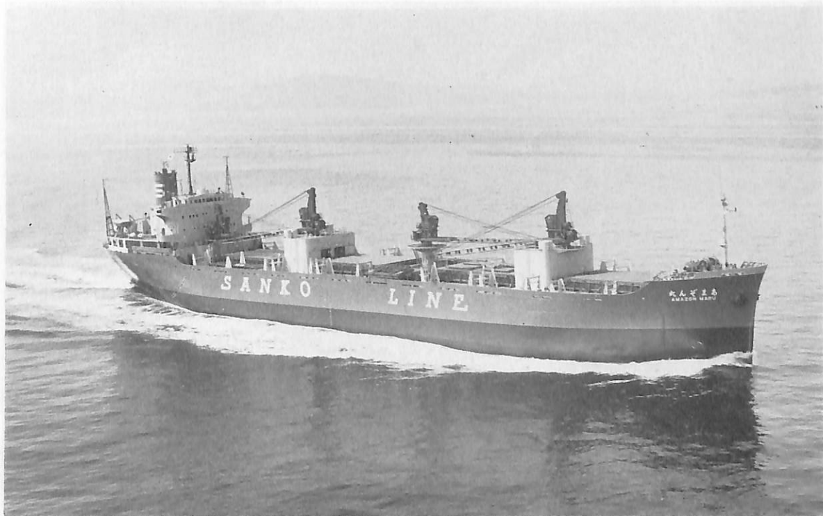
あ ま そ ん 丸 (自動車兼撤荷運搬船) 船 主 イースタンショッピング株式会社, 新光海運株式会社 造船所 株式会社 名村造船所 総噸数 12,357.59 噸 純噸数 7,195.82 噸 遠洋 船級 NK 載貨重量 18,790 噸 全長 150.11 m 長(垂) 143.00 m 幅(型) 22.70 m 深(型) 13.20 m 吃水 9.750 m 満載排水量 24,557 噸 主機 三菱スルザー 6 RD 68 型ディーゼル機関 1 基 出力 7,200 PS×145 RPM 燃料消費量 28.5 t/d 航続距離 15,700 海里 速力 14.6 ノット 貨物倉(ペール) 20,940 m 3 (グリーン) 21,405 m 3 燃料油倉 1,321.8 m 3 清水 倉 179.3 m 3 乗員 35 名 工期 46-10-23, 47-1-18, 47-3-28 本船の自動車積載方法はカーラタン カーエレベーター (4 基) による方式
