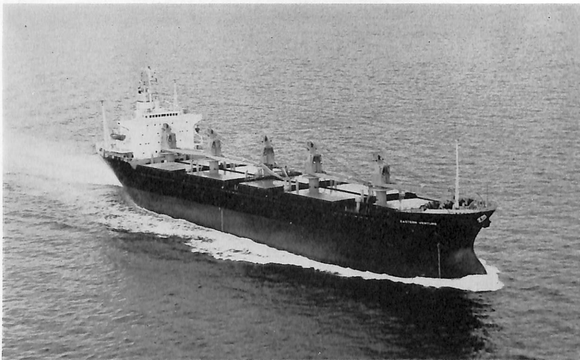
EASTERN VENTURE (貨物船) 船主 Harmony Carriers Inc. (リベリア) 造船所 株式会社 白杵鉄工所 佐伯造船所 総噸数 14,748.82 噸 純噸数 10,290.83 噸 遠洋 船級 LR 載貨重量 26,521 噸 全長 166.070 m 長(垂) 156.000 m 幅(型) 24.800 m 深(型) 14.350 m 吃水 10.456 m 満載排水量 33,054 噸 凹甲板型 主機 IHI-スルザー 6 RND 68 型ディーゼル機関 1 基 出力 8,415 PS×150 RPM 燃料消費量 154 g/BHP.h 航続距離 13,500 海里 速力 14.4 ノット 貨物倉(ベール) 32,444.95 m 3 (グレーン) 33,432.06 m 3 燃料油倉 1,639.90 m 3 清水倉 252.27 m 3 乗員 46 名 工期 46-7-28, 46-10-21, 46-12-17
