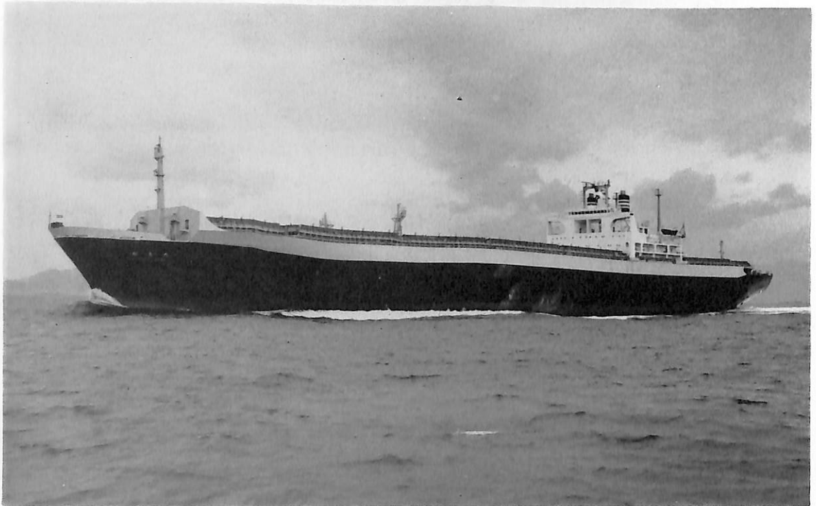
鞍 馬 丸 (コンテナ船) 船主 日本郵船株式会社 造船所 三菱重工業・神戸造船所 総噸数 51,139.76 噸 純噸数 30,993.91 噸 遠洋 船級 NK 載貨重量 35,396 噸 全長 261.00 m 長(垂) 245.00 m 幅(型) 32.20 m 深(型) 24.00 m 吃水 12.0305 m 満載排水量 58,058 噸 下降甲板付平甲板型 主機 三菱 ウェスチングハウス MS-4 D 型船用タービン 2 基 出力 2×36,000 PS×130 RPM 燃料消費量 351 t/d 速力 (試) 29.9 ノット (航) 27.1 ノット コンテナ積載数 ISO 型 20' 換算 1,838 箇 燃料油倉 12,120.1 m 3 清水倉 844.4 m 3 乗員 33 名 外 2 名 パイロット, 作業員 11 名 工期 46-3-20, 46-9-22, 47-3-10 同型船 鎌倉丸, らいん丸
