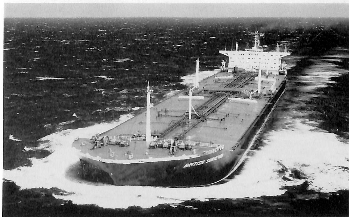
BRITISH SURVEYOR (油 槽 船) 船 主 BP. Medway Tanker Co, Ltd (イギリス) 造 船 所 三 井 造 船 ・ 千 葉 造 船 所 全 長 324.182 m 長 (垂) 309.982 m 幅 (型) 48.768 m 深 (型) 25.298 m 吃 水 19.653 m 総 噸 数 112,742.37 噸 載 貨 重 量 222,745 噸 貨 油 倉 272,381.6 噸 速 力 (試) 15.78 ノット 主 機 IHI 衝 動 船 用 タービ ン 1 基 出 力 30,000 PS×88 RPM 乗 員 48 名 船 級 LR 工 期 46-9, 46-12, 47-3-28 設 備 専 用 パ ラ ス ト タ ン ク の み で 離 着 岸 可 能, イ ナ ー ト ガ ス 装 置, 海 水 汚 濁 防 止 の た め 上 甲 板 に オ イ リ ー ウ ェ ー タ ー セ パ レ ー タ 装 備
