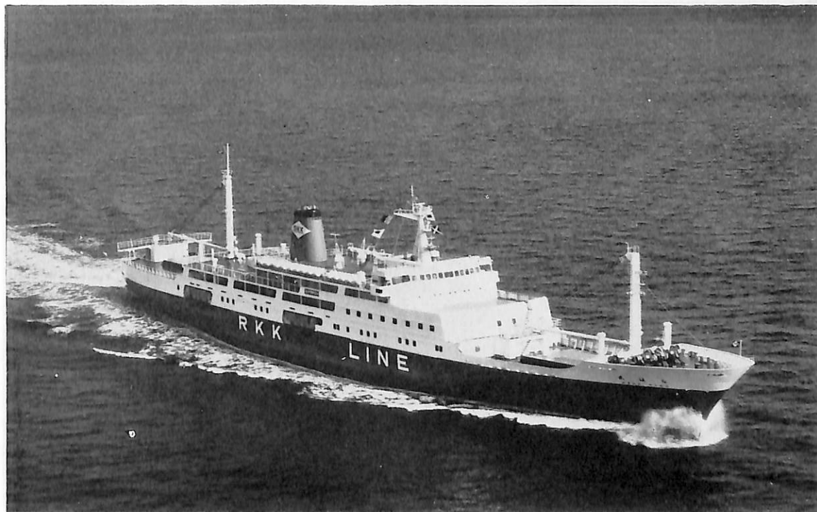
なは丸(貨客船) 船主 琉球海運株式会社 造船所 尾道造船株式会社 総噸数 4,957.88 噸 純噸数 2,825.58 噸 近海 船級 NK 載貨重量 2,924.88 噸 全長 130.85 m 長(垂) 120.00 m 幅(型) 16.80 m 深(型) 9.10 m 吃水 5.718 m 満載排水量 6,454.00 噸 覆甲板船型 主機 日立 B&W 1250 VT 2 BF 110 型ディーゼル機関 1 基 出力 8,400 PS×170 RPM 燃料消費量 33.60 t/d 航続距離 1,800 海里 速力 20.7 ノット 貨物倉(ベール) 2,505.85 m 3 燃料油倉 191.98 t 清水倉 533.37 t 乗員 49 名 工期 46-7-8, 46-11-19, 47-2-22
