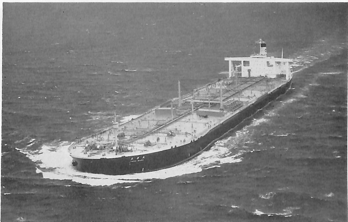
東 邦 丸 (油 槽 船) 船 主 飯野海運株式会社, 川崎汽船株式会社 造船所 川崎重工業・神戸工場 総噸数 115,943 噸 純噸数 89,035 噸 遠洋 船級 NK 全長 319.3 m 長(垂) 305.0 m 幅(型) 53.0 m 深(型) 25.3 m 吃水 19.54 m 満載排水量 266,205 噸 船首楼付平甲板船 主機 川崎 UA-360 スチームタービン 1 基 出力 35,000 PS×89 RPM 燃料消費量 174.9 t/d 航続距離 17,200 海里 速力 16.32 ノット 貨油倉 288,087 m 3 燃料油倉 8,552 m 3 清水倉 131 m 3 旅客 4 名 乗員 50 名 工期 46-5-24, 46-11-26, 47-3-11
