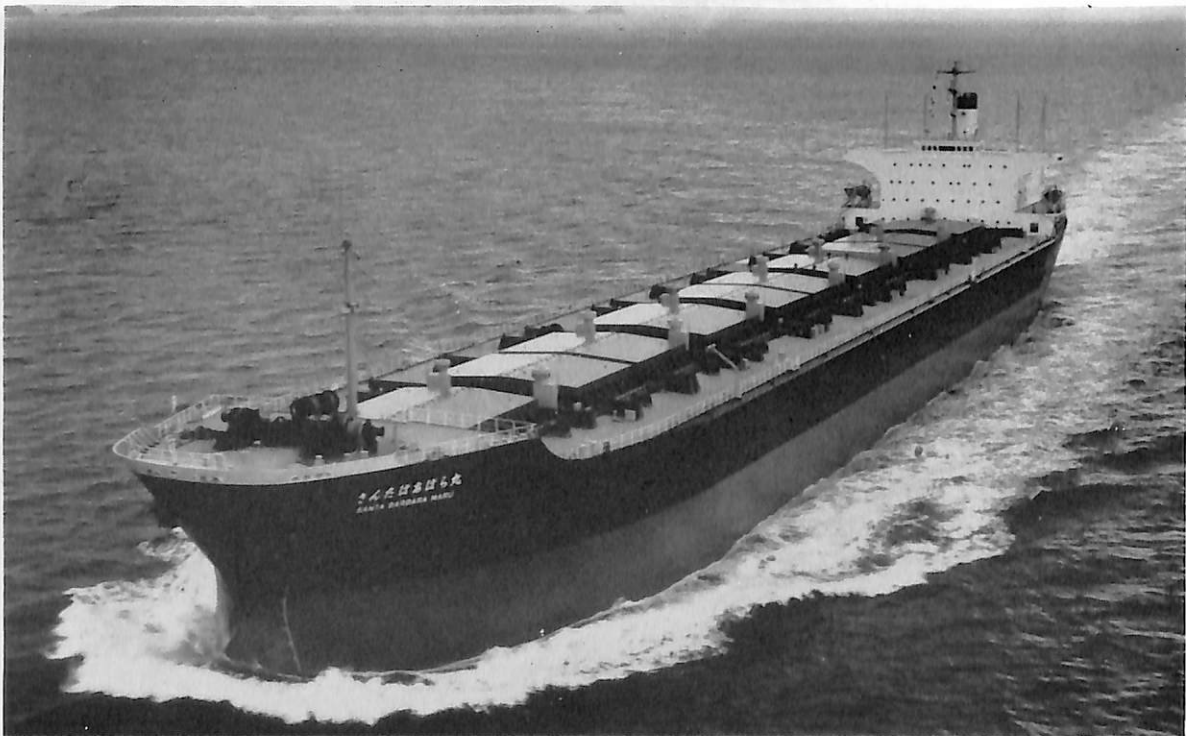
さんたばあばら丸 (ばら積貨物船) 船主 三菱鉱石輸送株式会社 造船所 三菱重工業・神戸造船所 総噸数 37,069.41 噸 純噸数 23,230.82 噸 遠洋 船級 NK 載貨重量 62,344 噸 全長 238.00 m 長(垂) 225.00 m 幅(型) 32.20 m 深(型) 18.20 m 吃水 12.2285 m 満載排水量 75,326 噸 船首楼付平甲板型 主機 三菱スルザー 6 RND 90 型ディーゼル機関 1 基 出力 15,660 PS×118 RPM 燃料消費量 63.9 t/d 航続距離 約 24,000 海里 速力 15.7 ノット 貨物倉(グリーン) 15,887.4 m 3 燃料油倉 4,239 m 3 清水倉 589.9 m 3 乗員 33 名 工期 46-7-1, 46-12-24, 47-3-22 同型船 紀見丸 M0 取得船
