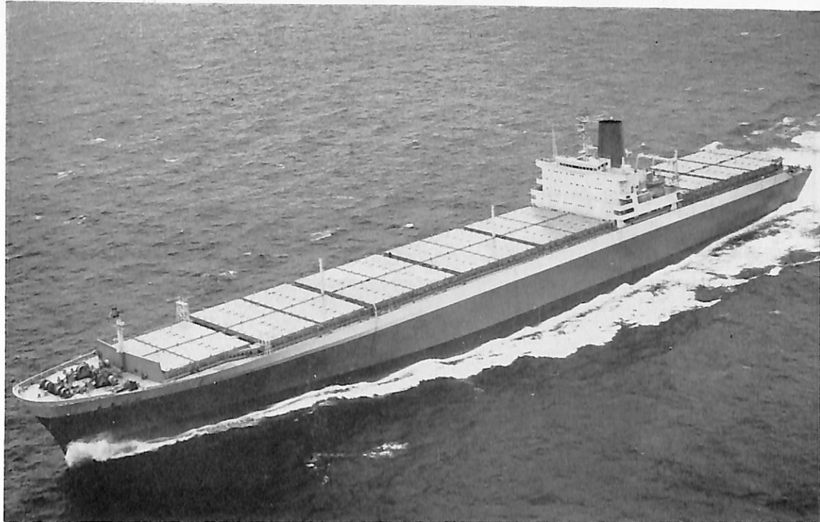
えるべ丸 (コンテナ船) 船主 大阪商船三井船舶株式会社 造船所 三井造船・玉野造船所 総噸数 51,623.17噸 純噸数 30,423.77噸 遠洋 船級 NK 載貨重量 35,229噸 全長 269.00 m 長(垂) 252.00 m 幅(型) 32.20 m 深(型) 24.40 m 吃水 12.00 m 主機 三井 B&W 12 K 84 EF 1 基 連続最大 33,800 PS×119 RPM 6 K 84 EF 2 基 连续最大 2×25,400 PS×119 RPM 速力(試) 30.96 ノット (航) 27.48 ノット コンテナ搭載数 倉内 20' コンテナ 672 箇 40' コンテナ 454 箇 甲板上 20' コンテナ 262 箇 20' コンテナ換算にて 計 1,842 箇 燃料油倉 C 8,662.7 t A 533.4 t 清水倉 336.7 m 3 乗組 37 名 工期 46-3 46-9, 47-3-24 設備 アンチローリングタンク, アンチピッチングタンク, (FLUMA STABILIZATION SYSTEM), 三菱 KAMAWA パウスラスター
