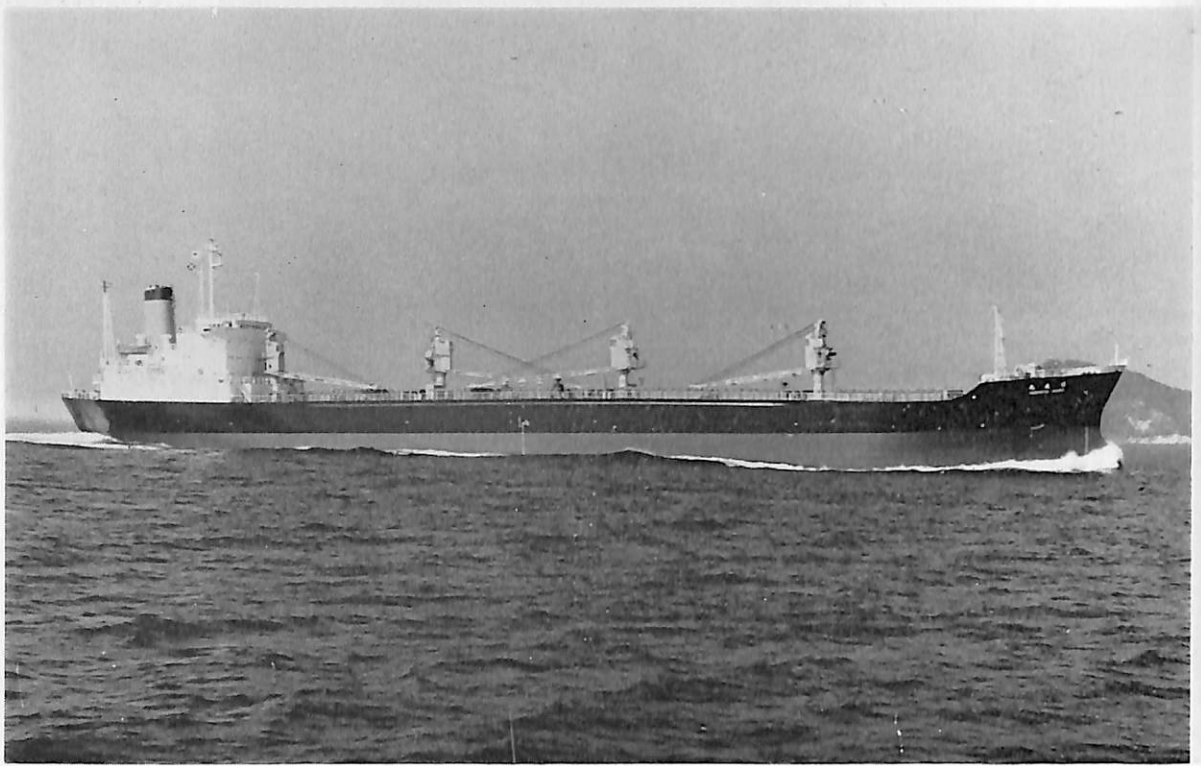
日 友 丸 (ニッケル鉱運搬船) 船主 山友汽船株式会社 造船所 笠戸船渠・笠戸造船所 総噸数 15,404.65 噸 純噸数 7,233.03 噸 遠洋 船級 NK 載貨重量 25,390 噸 全長 168.50 m 長(垂) 160.00 m 幅(型) 25.00 m 深(型) 13.00 m 吃水 9.433 m 満載排水量 31,233.03 噸 船首楼付平甲板型 主機 三菱 8 UEC 65/135 C 型ディーゼル機関 1 基 出力 8,840 PS×137.4 RPM 燃料消費量 33.6 t/d 航続距離 12,880 海里 速力 14.8 ノット 貨物倉(グリーン) 25,762.41 m 3 燃料油倉 1,318.42 m 3 清水倉 582.51 m 3 旅客 2 名 乗員 29 名 工期 46-6-23, 46-9-9, 46-11-30 設備 複索グラブバケット×4
