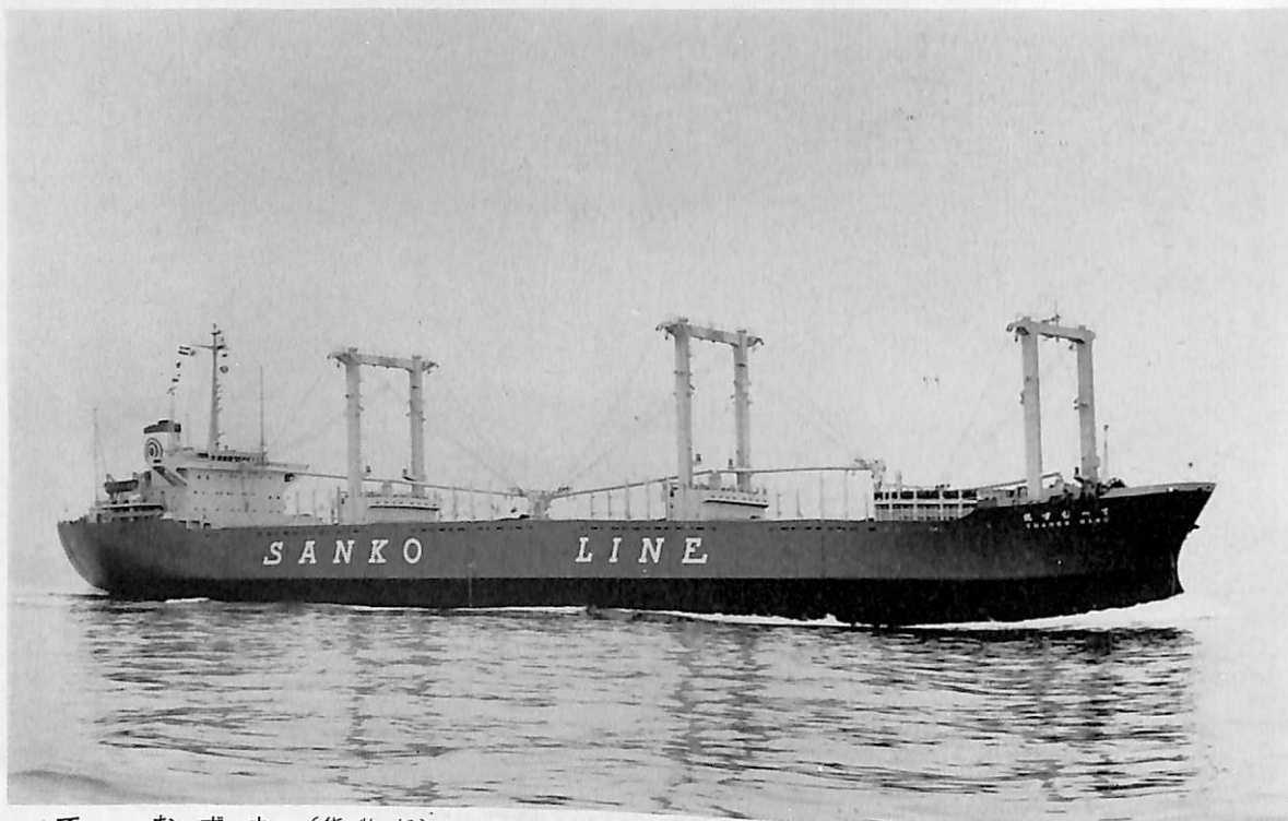
ていむず丸 (貨物船) 船主 新光海運株式会社 造船所 尾道造船株式会社 総噸数 20,356.72 噸 純噸数 13,897.61 噸 遠洋 船級 NK 載貨重量 34,596 噸 全長 179.90 m 長(垂) 170.00 m 幅(型) 28.40 m 深(型) 15.15 m 吃水 10.968 m 満載排水量 42,677 噸 凹甲板船尾機関型 主機 日立 B&W 6 K 74 EF 型ディーゼル機関 1 基 出力 10,600 PS×120 RPM 燃料消費量 42.6 t/d 航続距離 13,800 海里 速力 14.7 ノット 貨物倉(ベール) 42,163.30 m 3 (グリーン) 46,025.40 m 3 燃料油倉 1,674.38 t 清水倉 855.54 t 乗員 38 名 工期 46-7-13, 46-11-2, 47-2-10
