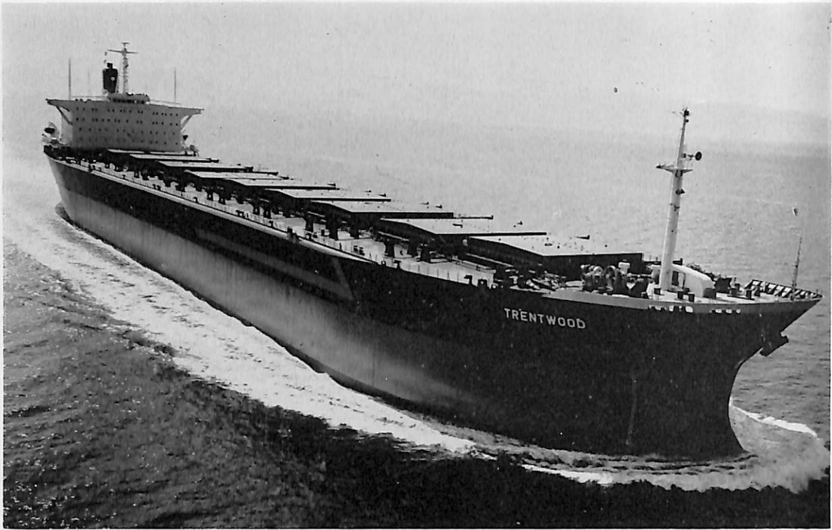
TRENTWOOD (ばら積貨物船) 船主 United International Ore Cassiers Ltd. (リベリア) 造船所 三菱重工業・広島造船所 総噸数 59,192.72 噸 純噸数 45,340 噸 遠洋 船級 AB 載貨重量 127,435 噸 全長 261.00 m 長(垂) 247.00 m 幅(型) 40.60 m 深(型) 24.00 m 吃水 57'-9 1 / 2 " 満載排水量 148,000 噸 平甲板型 主機 三菱スルザー 8 RND 90 型ディーゼル機関 1 基 出力 20,000 PS×116 RPM 燃料消費量 72 t/d 航続距離 約 25,600 海里 速力 14.8 ノット 貨物倉(グリーン) 141,174.6 m 3 燃料油倉 6,099.8 m 3 清水倉 698.0 m 3 乗員 40 名 工期 46-9-14, 46-12-17, 47-3-14
