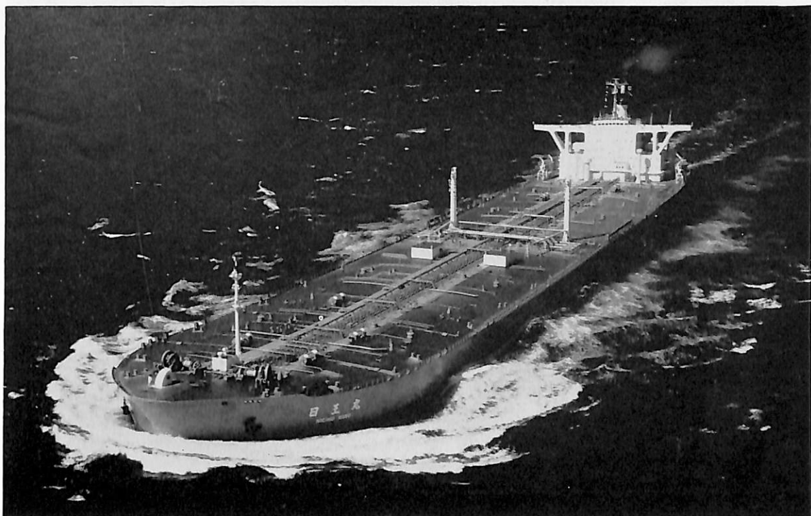
日 王 丸 (油 槽 船) 船 主 山 下 新 日 本 汽 船 株 式 会 社, 日 正 汽 船 株 式 会 社 造 船 所 日 立 造 船 ・ 堺 工 場 総 噸 数 120,255.21 噸 純 噸 数 90,612.13 噸 遠 洋 船 級 NK 載 貨 重 量 238,731 噸 全 長 324.00 m 長 (垂) 310.00 m 幅 (型) 53.00 m 深 (型) 25.00 m 吃 水 19.454 m 滿 載 排 水 量 272,088 噸 一 層 甲 板 船 主 機 日 立 UA-360 船 用 タービ ン 1 基 出 力 35,000 PS×89 RPM 燃 料 消 費 量 173.1 t/d 航 続 距 離 15,850 海 里 速 力 15.7 ノット 貨 油 倉 282,633.5 m 3 燃 料 油 倉 8,133.3 m 3 清 水 倉 610.6 m 3 乗 員 40 名 工 期 46-8-2, 46-12-15, 47-3-15 同 型 船 新 燕 丸
