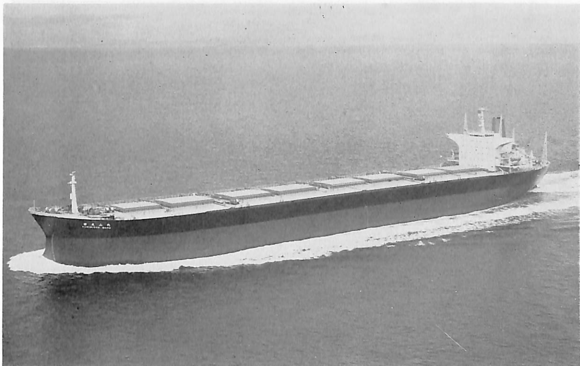
見山丸(鉱石運搬船) 船主 大阪商船三井船舶株式会社・馬場大光商船株式会社 造船所 三井造船・玉野造船所 全長 259.347 m 長(垂) 249.00 m 幅(型) 39.60 m 深(型) 22.00 m 吃水 16.152 m 総噸数 63,087.89 噸 載貨重量 116,524 噸 貨物倉 65,845.5 m 3 速力(試) 17.8 ノット 主機 三井 B&W 9 K 84 EF 型ディーゼル機関 1 基 出力(連続最大) 23,200 PS×114 RPM 乗員 28 名 船級 NK 工期 46-10, 46-12, 47-3-31 設備 貨物倉 4 倉, それぞれ 2 箇の片開き式サイドローリングスケルハッチカバー付, 三井 AEG ロータリーベイン型電動油圧式操舵機 BDC 800 型装備
