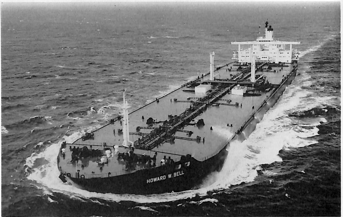
HOWARD W. BELL (油槽船) 船主 Chevron Transport Corporation (リベリア) 造船所 三菱重工業 長崎造船所 総噸数 118,341.93 噸 純噸数 100,178 噸 遠洋 船級 AB 載貨重量 264,077 噸 全長 337.70 m 長(垂) 320.00 m 幅(型) 53.60 m 深(型) 26.40 m 吃水 67'-4 1 / 8 " 満載排水量 299,381 噸 主機 三菱船用タ ービン 1 基 出力 32,000 PS×90 RPM 燃料消費量 156 t/d 航続距離 25,000 海里 速力 15.1 ノット 貨油倉 320,532.1 m 3 燃料油倉 12,296.6 m 3 清水倉 372.5 m 3 乗員 56 名(外予備 7 名) 工期 46-9-4, 46- 12-5, 47-3-30 同型船 George M. Keller
