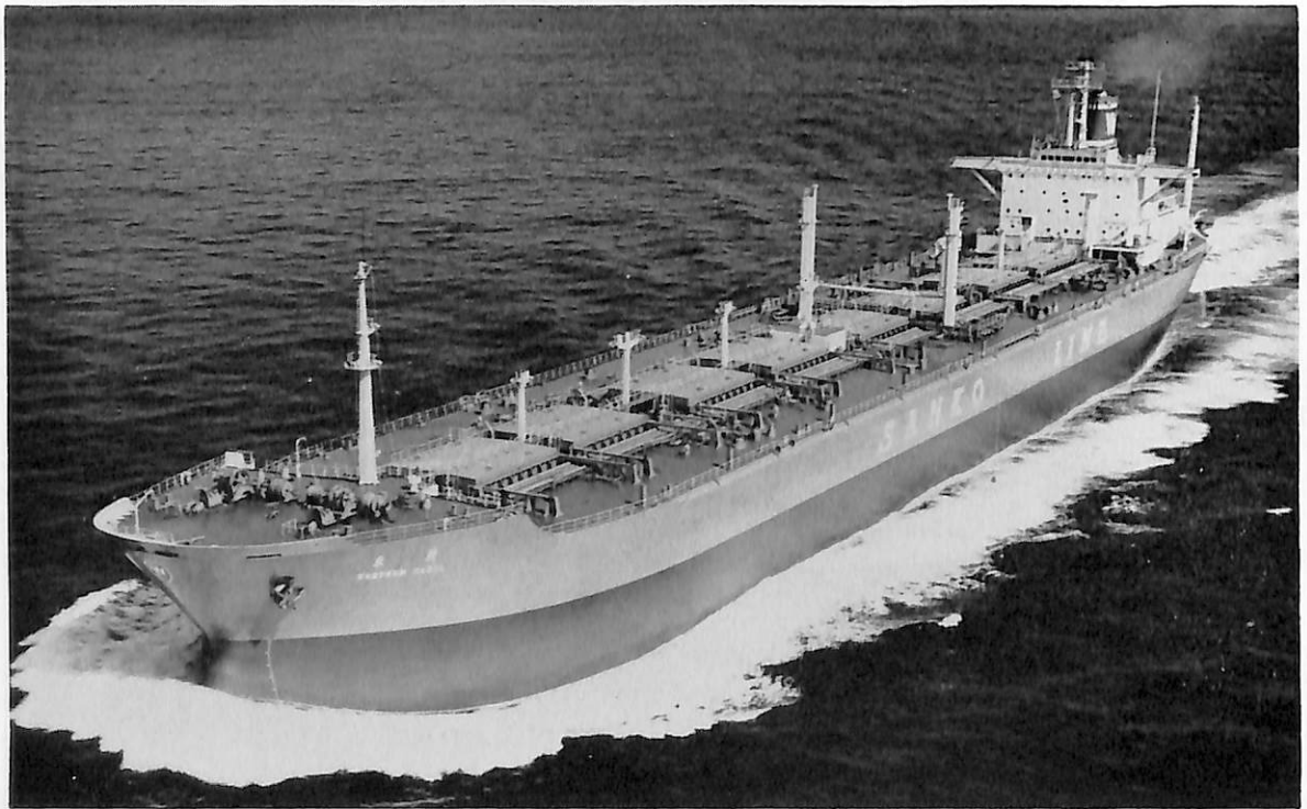
EASTERN HAZEL (鉍石兼油槽船) 船主 Liberian Hazel Transports, Ince (リベリア) 造船所 三菱 重工業・横浜造船所 総噸数 41,164.64 噸 純噸数 29,362 噸 遠洋 船級 BV 載貨重量 76,371 噸 全長 237.70 m 長(垂) 226.00 m 幅(型) 36.00 m 深(型) 19.10 m 吃水 13.299 m 満載排水量 99,362 噸 船首楼 付平甲板船 主機 三菱スルザー7RND90型ディーゼル機関 1 基 出力 18,270 PS×118 RPM 航続距離 29,000 海里 速力(試) 16.92 ノット (航) 15.9 ノット 貨油倉 93,372 m 3 貨物倉(グレーン) 40,648 m 3 燃料油倉 5,638 m 3 清水倉 456 m 3 乗員 34 名 外予備 8 名 工期 46-8-20, 46-12-15, 47-3-8 設備 イナートガスシステム装置
