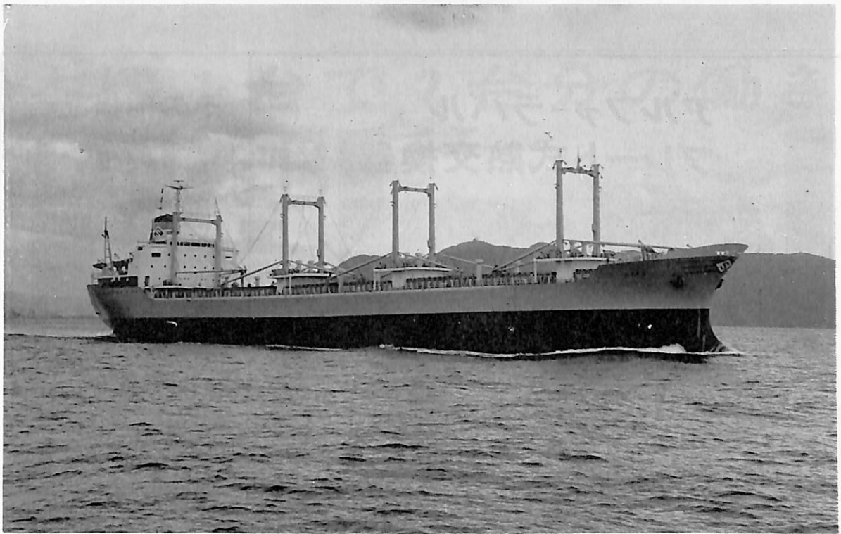
DIAS (ばら積貨物船) 船主 Dias Compania Naviera S.A. (ギリシヤ) 造船所 函館ドック株式会社・函館造船所 総噸数 16,605.93 噸 純噸数 11,884 噸 遠洋 船級 AB 載貨重量 28,855 噸 全長 180.80 m 長(垂) 170.00 m 幅(型) 23.10 m 深(型) 14.50 m 吃水 35'-0" 満載排水量 35,217 噸 船首尾楼付一層甲板船 主機 IHI-スルザー 6 RND 68 型ディーゼル機関 1 基 出力 7,650 PS×130 RPM 燃料消費料 28.6 t/d 航続距離 21,500 海里 速力 14.1 ノット 貨物倉(ベール) 1,178.828 ft 3 (グレーン) 1,338.108 ft 3 燃料油倉 72,093 ft 3 清水倉 22,903 ft 3 乗員 40 名 工期 46-6-23, 46-9-2, 46-11-10
