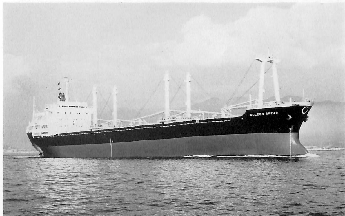
GOLDEN SPEAR (ばら積貨物船) 船主 Golden Nagos Steamship Inc. (リベリア) 造船所 日本鋼管・ 清水造船所 総噸数 12,959.41 噸 純噸数 8,719 噸 遠洋 船級 AB 載貨重量 22,076.1 噸 全長 155.70 m 長(垂) 145.70 m 幅(型) 22.86 m 深(型) 13.60 m 吃水 9.908 m 満載排水量 26,906.8 噸 凹甲板型 主機 住友スルザー 6 RND 68 型ディーゼル機関 1 基 出力 7,650 PS×130 RPM 燃料消費量 28.1 t/d 航続距離 27,300 海里 速力 15.1 ノット 貨物倉(ベール) 24,929.9 m 3 (グリーン) 28,474.5 m 3 燃料油倉 2,403.8 m 3 清水倉 84.3 m 3 乗員 40 名 工期 46-10-20, 47-1-8, 47-3-16
