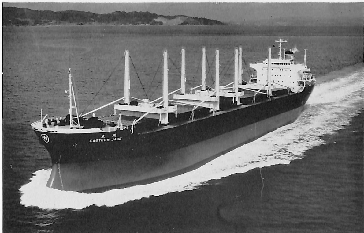
EASTERN JADE (ばら積貨物船) 船主 Liberian Jade Transports, Inc. (リベリア) 造船所 株式会社 大阪造船所 総噸数 19,654.24 噸 純噸数 13,871 噸 遠洋 船級 AB 載貨重量 33,673 噸 全長 185.500 m 長(垂) 175.00 m 幅(型) 26.00 m 深(型) 15.50 m 吃水 11.151 m 満載排水量 41,748 噸 凹甲板船 主機 IHI スルザー 7 RND 68 型ディーゼル機関 1 基 出力 10,395 PS×144.8 RPM 燃料消費量 約 42.03 t/d 航続距離 約 16,110 海里 速力 14.6 ノット 貨物倉(ベール) 41,242 m 3 (グリーン) 44,735 m 3 燃料油倉 2,164.9 m 3 清水倉 432.4 m 3 乗員 50 名 工期 46-9-28, 46-12-22, 47-3-7
