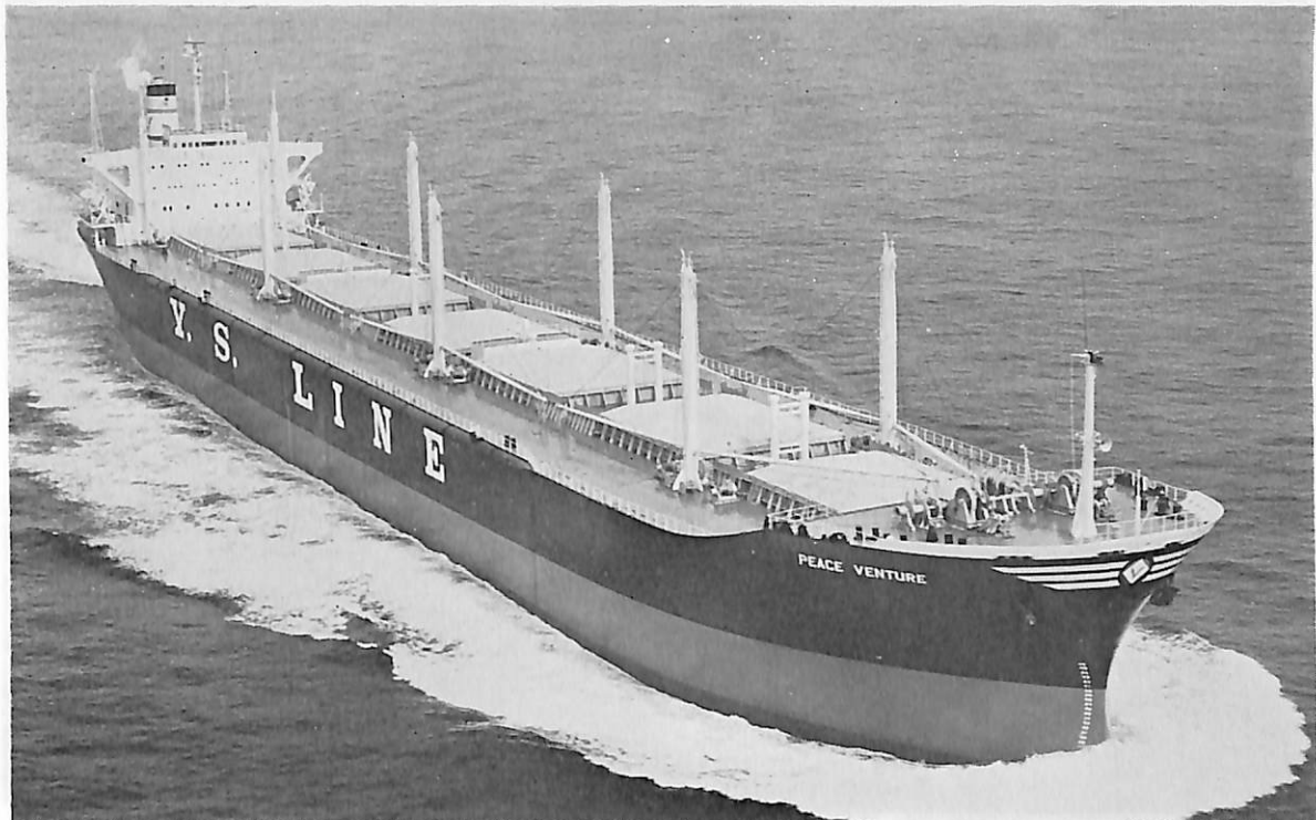
PEACE VENTURE (ばら積貨物船) 船主 Solar Carrier Inc. (リベリア) 造船所 日立造船・舞鶴工場 総噸数 30,568.94 噸 純噸数 23,696.95 噸 遠洋 船級 BV 載貨重量 60,506 噸 全長 225.00 m 長(垂) 215.00 m 幅(型) 32.20 m 深(型) 17.80 m 吃水 11.580 m 満載排水量 71,815 噸 一層甲板型 主機 日立スルザー 7 RND 76 型ディーゼル機関 1 基 出力 12,600 PS×118 RPM 燃料消費量 47.40 t/d 航続距離 23,960 海里 速力 14.80 ノット 貨物倉 74,211.00 m 3 燃料油倉 3,597.64 m 3 清水倉 440.38 m 3 乗員 46 名 工期 46-10-4 46-12-25, 47-3-31
