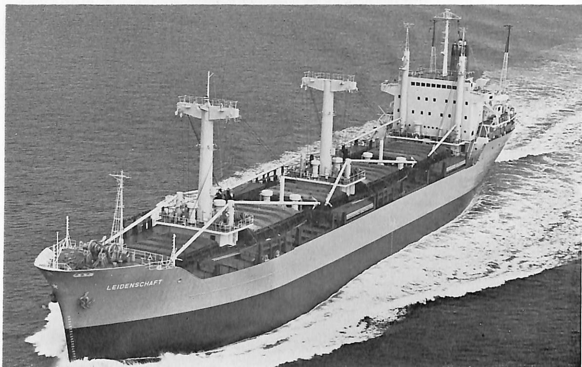
LEIDENSCHAFT (貨物船) 船主 Cygnus Navigatin Corporation. (リベリア) 造船所 日立造船・向島工場 総噸数 9,963.98 噸 純噸数 6,411.46 噸 遠洋 船級 LR 載貨重量 14,678 噸 全長 143.013 m 長(垂) 136.02 m 幅(型) 21.00 m 深(型) 12.20 m 吃水 39'-9 5 / 16 " 満載排水量 19,841 噸 二層甲板型 主機 日立 B&W 662-VT 2 BF-140 型ディーゼル機関 1 基 出力 6,550 PS×135 RPM 燃料消費量 26.3 t/d 航続距離 約 12,200 海里 速力 14.55 ノット 貨物倉(ベール) 679,019 ft 3 (グリーン) 739,165 ft 3 穀物の場合 787.276 ft 3 自動車搭載数 ブルーバード 815 台 燃料油倉 33,885 ft 3 清水倉 2,355 ft 3 乗員 40 名 工期 46-10-14, 46-12-23, 47-3-31
