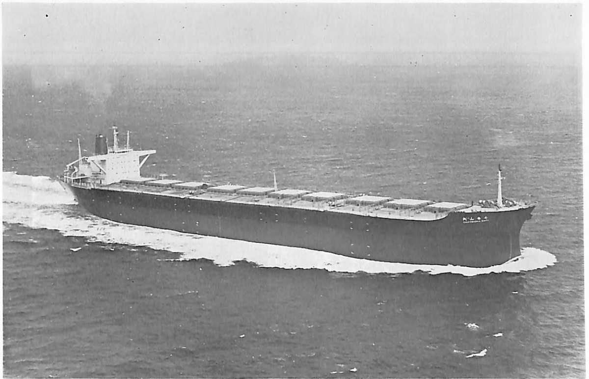
千 曲 山 丸 (鉾石運搬船) 船主 大阪商船三井船舶株式会社 造船所 川崎重工業・神戸工場 総噸数 86,460.46 噸 純噸数 32,040.85 噸 遠洋 船級 NK 載貨重量 160,533 噸 全長 289.00 m 長(垂) 275.00 m 幅(型) 44.00 m 深(型) 24.20 m 吃水(キール下面より) 17.942 m 満載排水量 186,958 噸 主機 川崎 MAN K 8 SZ 105/180 型ディーゼル機関 1 基 出力(連続最大) 30,400 PS×106 RPM (常用) 25,800 PS×約 100 RPM 航続距離 41,100 海里 速力(試) 17.938 ノット(航) 15.48 ノット 鉾石倉 92,455.3 m 3 燃料油倉 12,239.00 m 3 清水倉 592.6 m 3 乗員 28 名 工期 46-8-30, 46-12-18, 47-3-23
