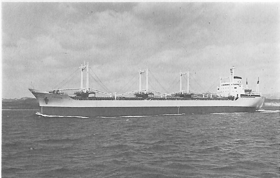
TRITON (ばら積貨物船) 船主 Tritonas Compania Naviera S.A.(ギリシア) 造船所 函館ドック・函館造船所 総噸数 16,605.93 噸 純噸数 11,884 噸 遠洋 船級 AB 載貨重量 28,857 噸 全長 180.80 m 長(垂) 170.00 m 幅(型) 23.10 m 深(型) 14.50 m 吃水 35'-0" 満載排水量 35,217 噸 船首尾機付一層甲板船 主機 IHI-スルザー 6 RND 68 型ディーゼル機関 1 基 出力 7,650 PS×130 RPM 燃料消費量 28.6t/d 航続距離 約 21,500 海里 速力 約 14.1 ノット 貨物倉(ベール) 1,178,828 ft 3 (グリーン) 1,338,108 ft 3 燃料油倉 C 72,093 ft 3 A 6,352 ft 3 清水倉 22,903 ft 3 乗員 40 名 工期 46-11-15, 47-2-10, 47-3-30
