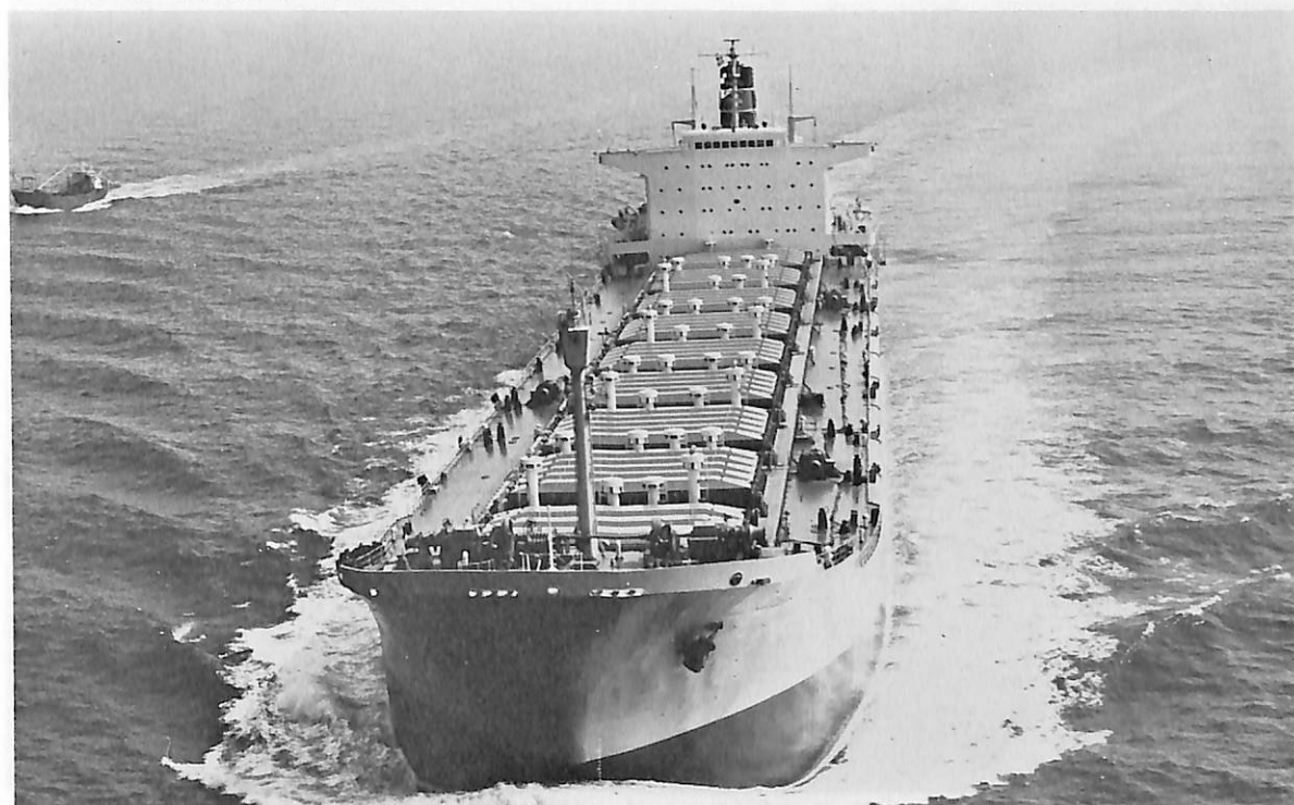
KONKAR INDOMITABLE (ばら積貨物船) 船主 Konkter Indomitable Corp. (リベリア) 造船所 三井造船・玉野造船所 全長 259.528 m 長(垂) 249.00 m 幅(型) 32.156 m 深(型) 18.593 m 吃水 13.640 m 総噸数 39,453.41 噸 載貨重量 77,992 噸 貨物倉 91,470 m 3 速力 16.73 ノット 主機 三井 B&W 7 K 84 EF 型ディーゼル機関 1 基 出力(連続最大) 17,500 PS×114 RPM 乗員 42 名 船級 AB 工期 46-11, 47-1, 47-4-26
