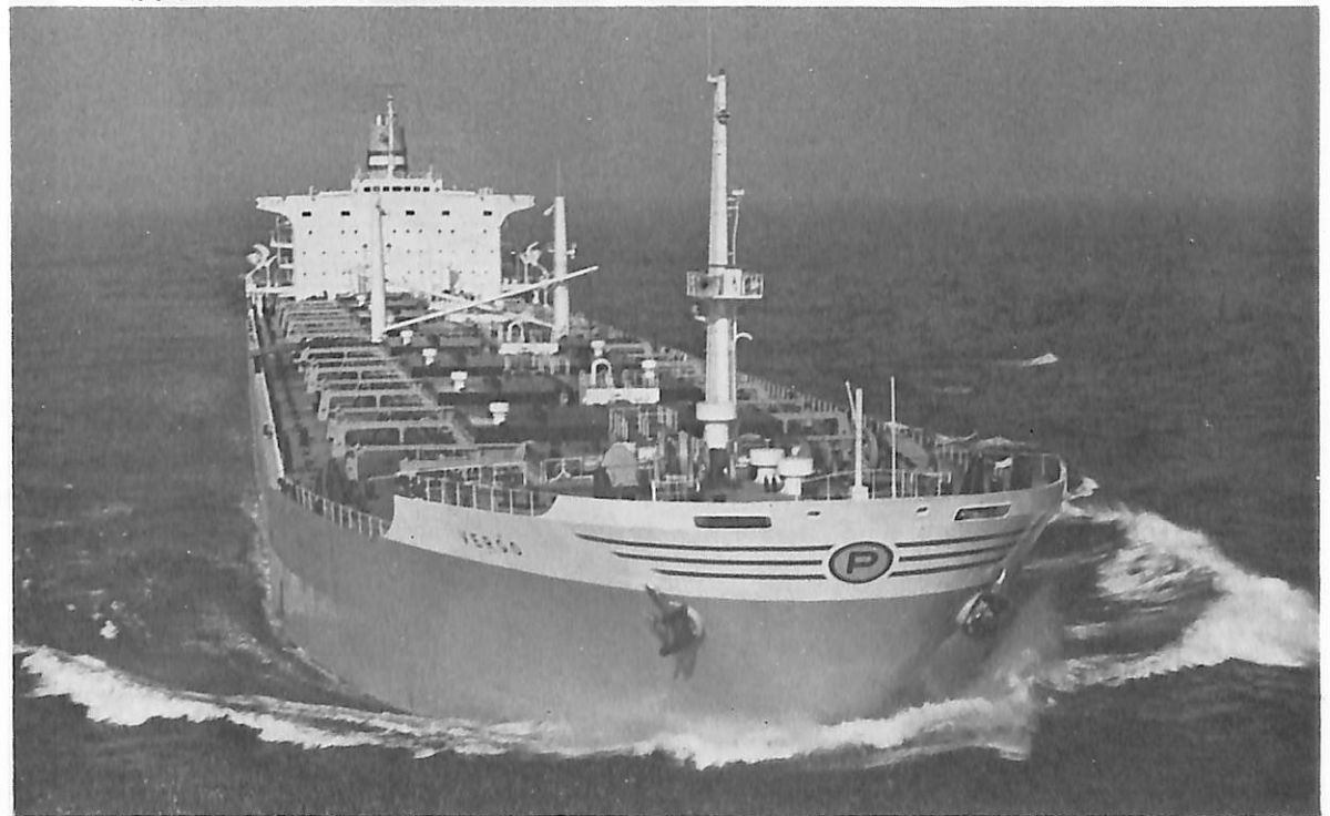
VERGO (鉾石、ばら積兼油槽船) 船主 Peonia Compania Naviera S. A. (パナマ) 造船所 日本鋼管・鶴見造船所 総噸数 57,526.67 噸 純噸数 46,269.09 噸 遠洋 船級 LR 載貨重量 112,015 噸 全長 264.32 m 長(垂) 252.00 m 幅(型) 38.00 m 深(型) 22.4 m 吃水 54'-1 1/8" 満載排水量 132,433 噸 主機 住友スルザー 8 RND 90 型ディーゼル機関 1 基 出力 20,000 PS×116 RPM 燃料消費量 72.4 t/d 航続距離 20,000 海里 速力 15.45 ノット 貨物倉(グリーン) 126,684 m 3 燃料油倉 4,293 m 3 清水倉 464.0 m 3 乗員 48 名 工期(起工) 46-10-1, (進水) 船尾 46-12-28 船首 47-1-9, (竣工) 47-4-27
