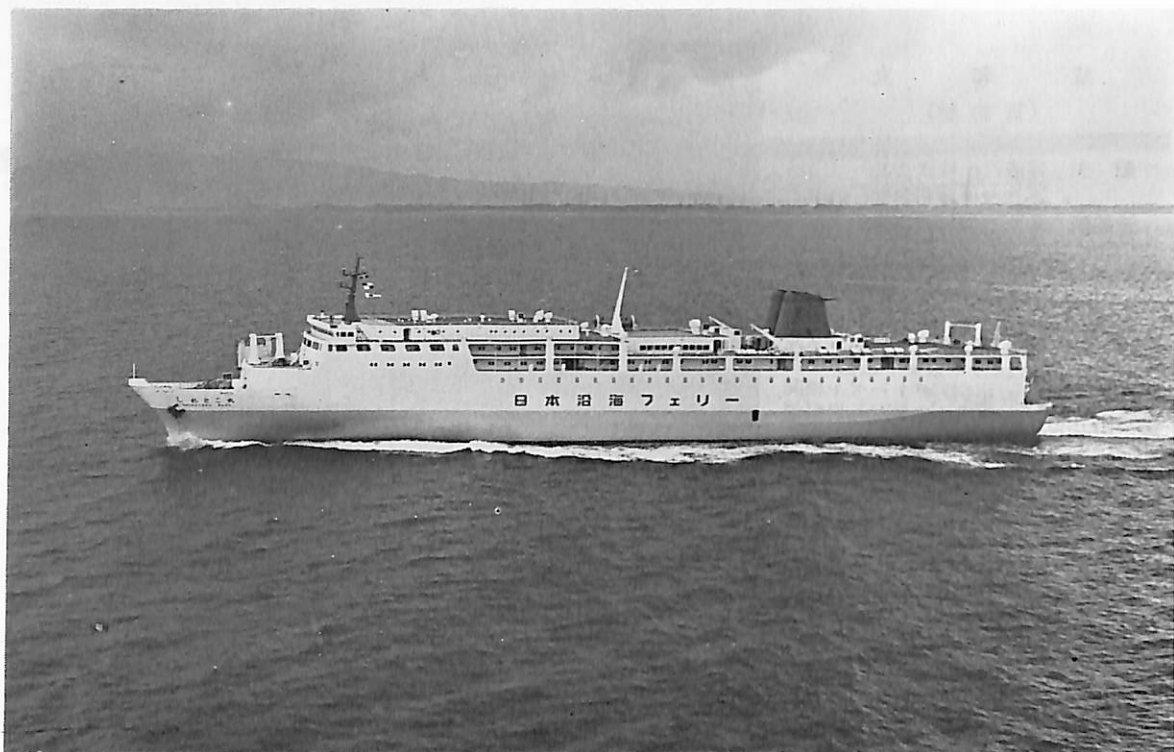
しれとこ丸 (自動車航送客船) 船主 日本沿海フェリー株式会社 造船所 株式会社 金指造船所 総噸数 7,875.33 噸 純噸数 3,750.92 噸 載貨重量 3,750.92 噸 全長 153.55 m 長(垂) 142.00 m 幅(型) 22.80 m 深(型) 8.00 m 吃水 6.02 m 満載排水量 10,349 噸 全通船楼型 主機 川崎 MAN V9 V 40/54 トランクピストン非逆転式ディーゼル機関 2 基 出力 2×8,500 PS×407 RPM 燃料消費量 152 g/ps.h 航続距離 2,800 海里 速力 20.3 ノット 自動車積載台数 トラック 114 台 乗用車 110 台 燃料油倉 A 138.01 m 3 B 488.25 m 3 清水倉 546.30 m 3 旅客 761 名 乗員 61 名 工期 46-6-23, 47-12-20, 47-4-20 設備 可変ピッチプロペラ, フィンスタビライザ, ハウスラスタ, 自動車荷役用ランプウェイ装備
