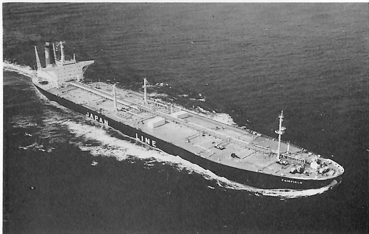
ジャパン アイリス (油槽船) 船主 ジャパンライン株式会社 造船所 石川島播磨重工・呉工場 総噸数 130,419.11 噸 純噸数 97,247.14 噸 遠洋 船級 NK 載貨重量 252,059 噸 全長 336.34 m 長(垂) 320.00 m 幅(型) 54.50 m 深(型) 26.00 m 吃水 19.588 m 平甲板船 主機 IHI コンベンショナルスチーム タービン 1 基 出力 36,000 PS×18.6 RPM 燃料消費量 174 t/d 航続距離 15,820 海里 速力 16.48 ノット 汽缶 IHI-MDM 901×2 貨油倉 316,269.09 m 3 燃料油倉 7,731.59 m 3 清水倉 1,025.00 m 3 乗員 36 名 工期 46- 9-21, 46-12-22, 47-4-14
