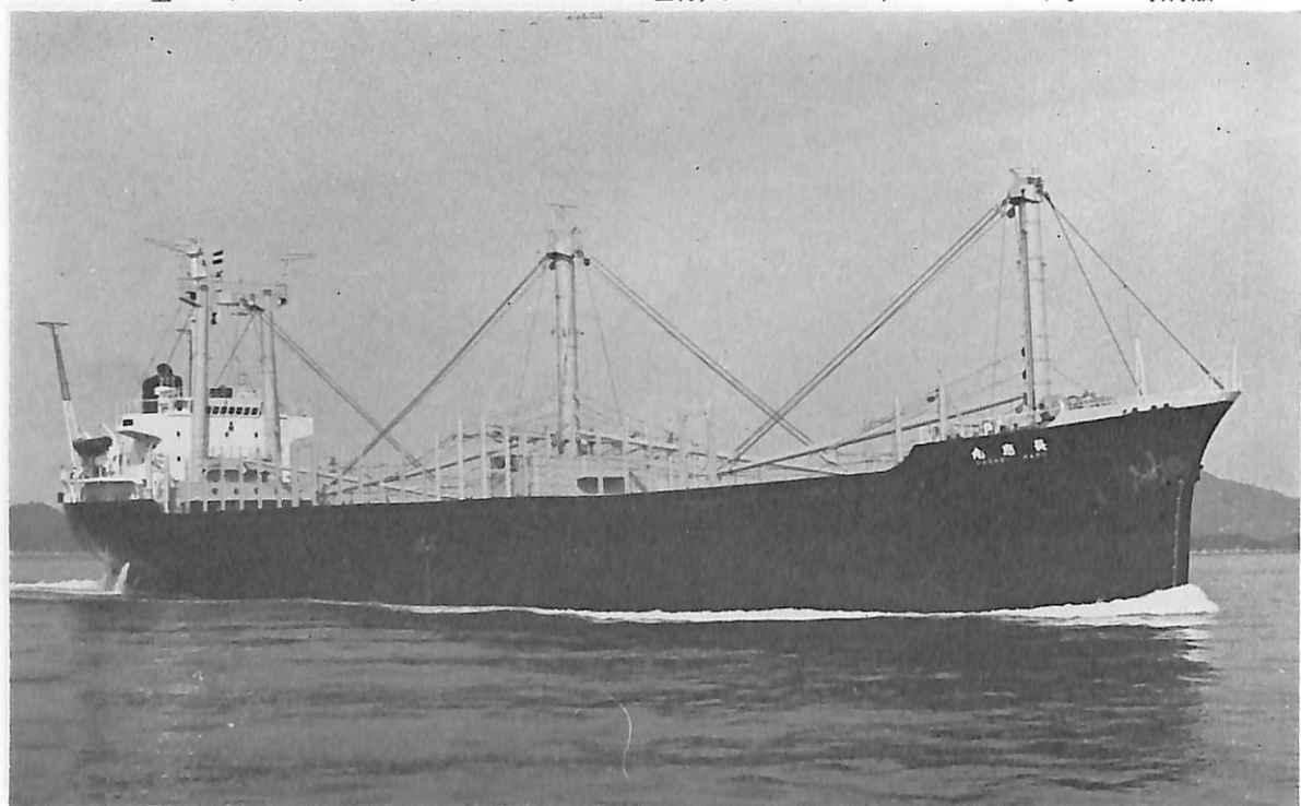
長恵丸 (貨物船) 船主 瀬野汽船株式会社 造船所 今治造船株式会社 総噸数 4,997.68 噸 純噸数 3,635.61 噸 遠洋 船級 NK 載貨重量 9,867.50 噸 全長 124.30 m 長(垂) 117.00 m 幅(型) 19.50 m 深(型) 9.75 m 吃水 7.500 m 満載排水量 12,900 噸 ウェル甲板船 主機 神戸発動機 6 UI C 52/105 D 型ディーゼル機関 1 基 出力 5,580 PS×169 RPM 燃料消費量 23.151 t/d 航続距離 13,420 海里 速力 13.84 ノット 貨物倉(ベール) 12,490.95 m 3 (グリーン) 13,241.96 m 3 燃料油倉 1,086.60 m 3 清水倉 529.39 m 3 乗員 28 名 工期 46-8-25, 47-1-14, 47-2-19
