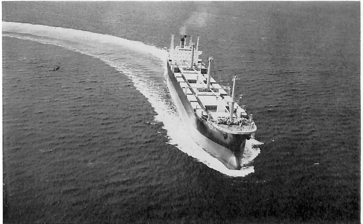
東 敬 丸 (穀類, 自動車運搬船) 船主 東興海運株式会社 造船所 株式会社 来島どっく大西工場 総噸数 16,176.91 噸 純噸数 10,462.81 噸 遠洋 船級 NK 載貨重量 26,260 噸 全長 178.50 m 長(垂) 168.00 m 幅(型) 22.86 m 深(型) 14.40 m 吃水 10.322 m 満載排水量 33,740 噸 主機 川崎 MAN K 8 Z 70/120 E 型ディーゼル機関 1 基 出力 10,080 PS×135 RPM 燃料消費量 154 g/ps/h 航続距離 11,500 海里 速力 17.548 ノット 貨物倉(ペール) 29,330.80 m 3 (グレーン) 30,161.20 m 3 燃料油倉 1,609.61 m 3 清水倉 526.56 m 3 乗組 29 名, 外 2 名 工期 46-6-27, 47-1-9, 47-3-15
