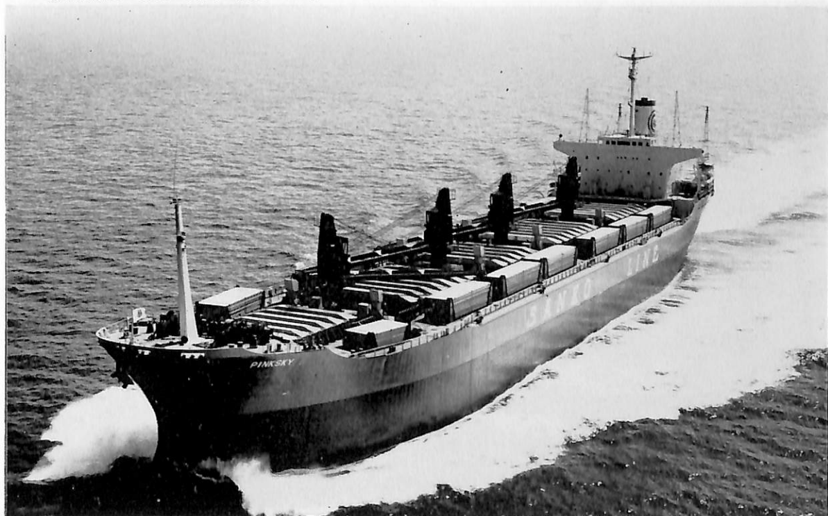
PINKSKY (ばら積貨物船) 船主 Oceanic Freighter Corporation (リベリア) 造船所 住友重機械工業・浦賀造船所 長(垂) 170.00 m 幅(型) 28.40 m 深(型) 15.00 m 吃水 10.83 m 総噸数 18,723.97 噸 載貨重量 33,789 噸 速力 14.8 ノット 主機 住友スルザー7RD 96 型ディーゼル機関 1 基 出力 11,200 PS×122 RPM 船級 BV 工期 46-10-7, 46-12-27, 47-3-28 同型船 DLUESKY 設備: トップサイドタンクの一部はグリーン専用, 鋼材およびメイズ積込用設備, カーゴウィンチのワンマンコントロール
