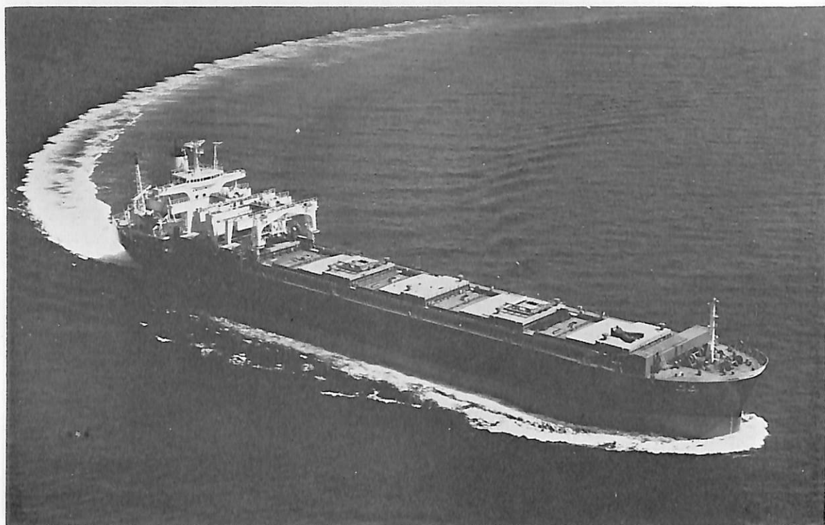
森丸 (チップ運搬船) 船主 明治海運株式会社 造船所 三井造船・藤永田造船所 全長 182.60 m 長(垂) 172.00 m 幅(型) 27.80 m 深(型) 18.50 m 吃水 10.024 m 総噸数 25,795.48 噸 載貨重量 31,144 噸 貨物倉(ベール) 56,296 m 3 (グリーン) 59,871 m 3 速力(試) 16.5 ノット (満載航海) 14.6 ノット 主機 三井 B&W 6 K 74 EF 型ディーゼル機関 1 基 出力(連続最大) 11,600 PS×124 RPM (常用) 9,900 PS×117.5 RPM 乗員 34 名 船級 NK 工期 46-10, 46-12, 47-4-11 荷役設備: 250 t/h 三井 パセコ型ガントリークレーン (10.5 t シブクレーン 2 基付), 500 t/h ベルトコンベヤー 1 組。M0 取得船
