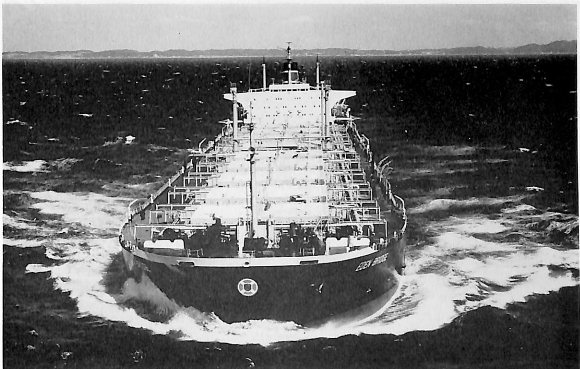
EDEN BRIDGE (鉾石, ばら積兼油槽船) 船主 H. Clarkson and Company Ltd. (英) 造船所 住友重機械工業・浦賀造船所 長(垂) 258.00 m 幅(型) 44.00 m 深(型) 24.5 m 吃水 18.097 m 総噸数 79,316.57 噸 載貨重量 142,762 噸 速力 15.5 ノット 主機 住友スルザー10RND 90 型ディーゼル機関 1 基 出力 29,000 PS×122 RPM 船級 LR 工期 46-8-18, 46-11-19, 47-3-14 設備: 1. カーゴコントロールルームにリモートレベルゲージ装備 2. イナートガスシステム 3. ロイドの UMS 規格取得 (機関室無人化) 4. 二重船底を傾斜し, 浅油の排出を容易にした。
