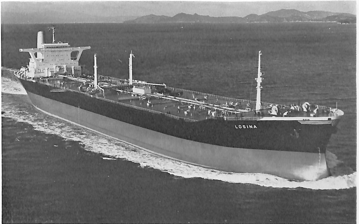
LOSINA (油槽船) 船主 Lcsina Shipping Ine. (リベリア) 造船所 日立造船・因島工場 総噸数 58,184.88 噸 純噸数 45,835.40 噸 遠洋 船級 BV 載貨重量 126,505 噸 全長 278.00 m 長(垂) 265.00 m 幅(型) 44.20 m 深(型) 21.50 m 吃水 15.60 m 満載排水量 149,088 噸 一層甲板船 主機 日立 B&W 10 K 84 EF 型ディーゼル機関 1 基 出力 22,700 PS×110 RPM 燃料消費量 85.5 t/d 航続距離 17,600 海里 速力 15.60 ノット 貨油倉 152,866.85 m 3 燃料油倉 4,209.52 m 3 清水倉 16,504 m 3 乗員 46 名 工期(起工) 46-9-3, (進水) 船首側 46-10-4, 船尾側 46-11-30, (竣工) 47-3-14
