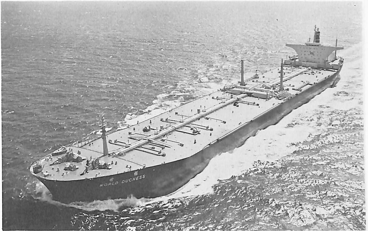
WORLD DUCHESS (油槽船) 船主 Libelian Flame Transports, Inc. (リベリア) 造船所 佐世保重工業 ・佐世保造船所 総噸数 98,896.68 噸 純噸数 80,112.45 噸 遠洋 船級 LR 載貨重量 221,121 噸 全長 326.00 m 長(垂) 313.00 m 幅(型) 48.20 m 深(型) 25.50 m 吃水 19,984 m 凹甲板船型 主機 川崎タービン UA-350 型 1 基 出力 33,000 PS×95 RPM 燃料消費量 214.7 g'ps/h 航続距離 17,100 海里 速力 1 6.13 ノット 燃料油倉 263,305 m 3 清水倉 921.9 m 3 乗員 60 名 工期 46-9-22, 46-12-12, 47-4-12 同型船 WORLD GENERAL
