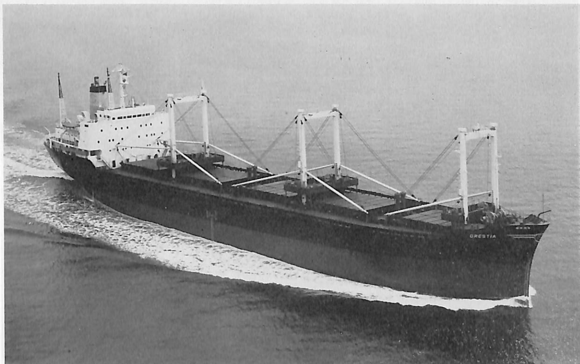
ORESTIA (ばら積貨物船) 船主 Incaica Compania Armadora S.A. (パナマ) 造船所 日立造船・向島工場 総噸数 12,110.59 噸 純噸数 8,037 噸 遠洋 船級 AB 載貨重量 19,198 噸 全長 156.16 m 長(垂) 146.00 m 幅(型) 22.60 m 深(型) 12.90 m 吃水 31'-3 3 / 4 " 満載排水量 24,197 噸 一層甲板船 主機 日立 B&W 6 K 62 EF 型ディーゼル機関 1 基 出力 7,600 PS×140 RPM 燃料消費量 約 30 t/d 航続距離 約 15,150 海里 速力 14.85 ノット 貨物倉(ベール) 23,610.24m 3 (グリーン) 24,303.57m 3 燃料油倉 1,508.76 m 3 清水倉 260.79 m 3 乗員 43 名 工期 46-11-17, 47-2-3, 47-4-17
