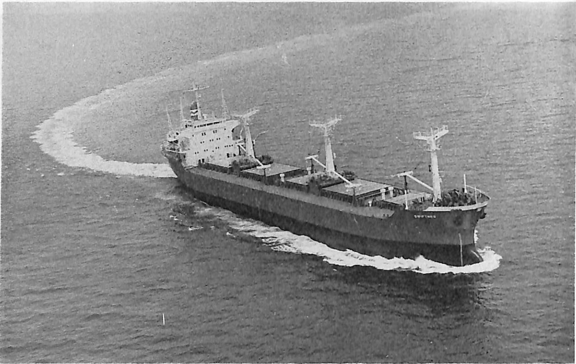
SWIFITNESS (ばら積貨物船) 船主 H. Clarkson & Co. Ltd. (イギリス) 造船所 日本鋼管・清水造船所 総噸数 12,982.17 噸 純噸数 8,106.22 噸 遠洋 船級 LR 載貨重量 21,916 噸 全長 155.517 m 長(垂) 145.70 m 幅(型) 22.86 m 深(型) 13.40 m 吃水 9.839 m 満載排水量 24,684 噸 凹甲板船 主機 NKK-S.E.M.T. ピー ルスチック 12 PC-2 V 400 型ディーゼル機関 1 基 出力 8,100 PS×500/126 RPM 燃料消費量 155.2 g/ps/h 航続距離 13,100 海里 速力 14.8 ノット 貨物倉(ベール) 25,852.1 m 3 (グレーン) 26,892.1 m 3 燃料油倉 1,402.4 m 3 清水倉 125.0 m 3 乗員 29 名(その他 3 名) 工期 46-12-10, 47-2-29, 47-5-25
