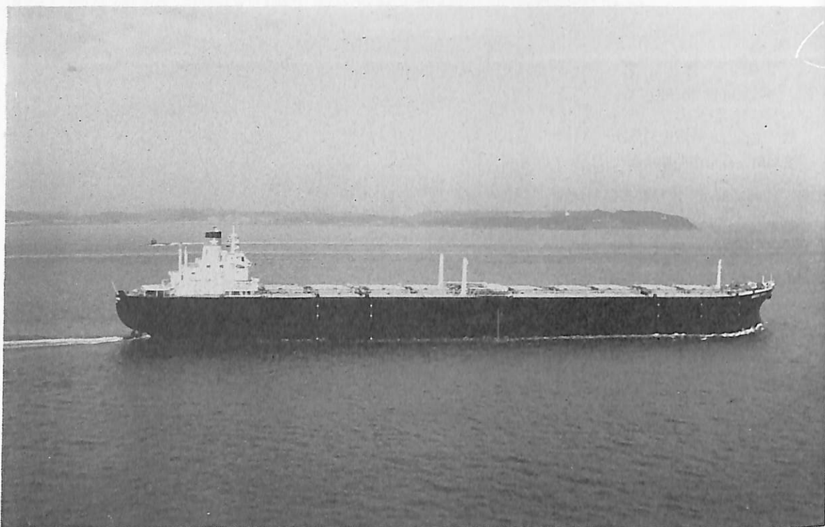
ANDROS ARIES (鉱石兼油槽船) 船主 Gulf Transport Corporation (ギリシヤ) 造船所 石川島播磨重工・横浜工場 総噸数 87,518.57 噸 純噸数 40,663 噸 遠洋 船級 AB 載貨重量 227,396 噸 全長 323.60 m 長(垂) 307.00 m 幅(型) 48.15 m 深(型) 27.45 m 吃水 67'-2 1 / 2 " 平甲板型 主機 IHI-船用タービンシングルブレン型×1 基 出力 28,000 PS×95 RPM 燃料消費量 142.5 t/d 航続距離 26,600 海里 速力 15.1 ノット 汽缶 IHI-F.W-DM 480 型×2 貨物倉(グレーン) 117.186 m 3 貨油倉 289.451 m 3 燃料油倉 12,292 m 3 清水倉 815 m 3 乗員 48 名 工期 46-7-1, 46-12-4, 47-3-11
