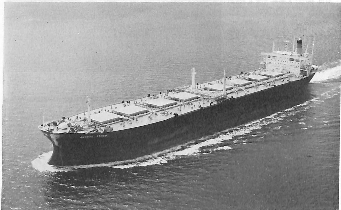
ANDROS STORM (鉱石兼油槽船) 船主 General Sea Transport Corp. (ギリシヤ) 造船所 石川島播磨重工・呉工場 総噸数 59,160.03 噸 純噸数 30,523 噸 遠洋 船級 AB 載貨重量 146,346 噸 全長 275.00 m 長(垂) 260.00 m 幅(型) 43.30 m 深(型) 24.70 m 吃水 59'-10" 平甲板船 主機 IHI-船用タービンシングルブレン型1 基 出力 19,000 PS×101.5 RPM 燃料消費量 96.3 t/d 航続距離 32,670 海里 速力 15.25 ノット 汽缶 IHI-F.W.MDM 651 型×2 貨物倉(グレーン) 80,550 m 3 貨油倉 179,667 m 3 燃料油倉 9,385 m 3 清水倉 747 m 3 乗員 46 名 工期 46-11-10, 47-2-18, 47-5-4
