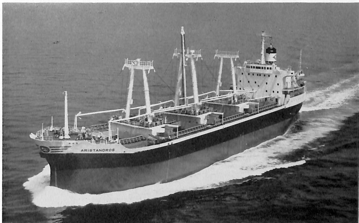
ARISTANDROS (貨物船) 船主 Inperio Trancoceanico S.A (パナマ) 造船所 三井造船・藤永田造船所 全長 147.70 m 長(垂) 140.00 m 幅(型) 22.86 m 深(型) 13.00 m 吃水 9.611 m 総噸数 11,721.70 噸 載貨重量 18,560 噸 貨物倉(ベール) 23,479 m 3 (グリーン) 25,467 m 3 速力 15.0 ノット 主機 三井 B&W 7 K 62 EF 型ディーゼル機関 1 基 出力(定格) 9,400 PS×144 RPM (常用) 8,600 PS×140 RPM 船級 LR 工期 46-10, 47-1, 47-5-25 設備:ロイド船級 UMS 取得
