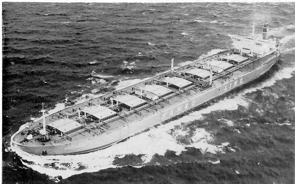
WORLD SPLENDOUR (鉱,ばら兼油槽船) 船主 Liberian Wasp Trausports, Inc. (リベリア) 造船所 三菱重工業・横浜造船所 総噸数 89,138.61 噸 純噸数 71,875.74 噸 遠洋 船級 BV 載貨重量 164,190 噸 全長 295.00 m 長(垂) 280.00 m 幅(型) 47.40 m 深(型) 24.80 m 吃水 17.40 m 主機 三菱 2段減速装置付 舶用タービン 1基 出力 28,000 PS×88 RPM 燃料消費量 139.0 t/d 航続距離 25,000 海里 速力 16.0ノット 貨物倉(グリーン) 145,846 m 3 貨油倉 214.829 m 3 燃料油倉 10,402 m 3 清水倉 532 m 3 乗員 50名 工期(起 工) 46-9-16, (進水) A.B 47-1-22 F.B 47-2-24, (竣工) 47-5-31 同型船 GOLDEN CLOVER GOLDEN TULIP 設備 イナートガス装置, 大型タンククリーニングマシン 110台
