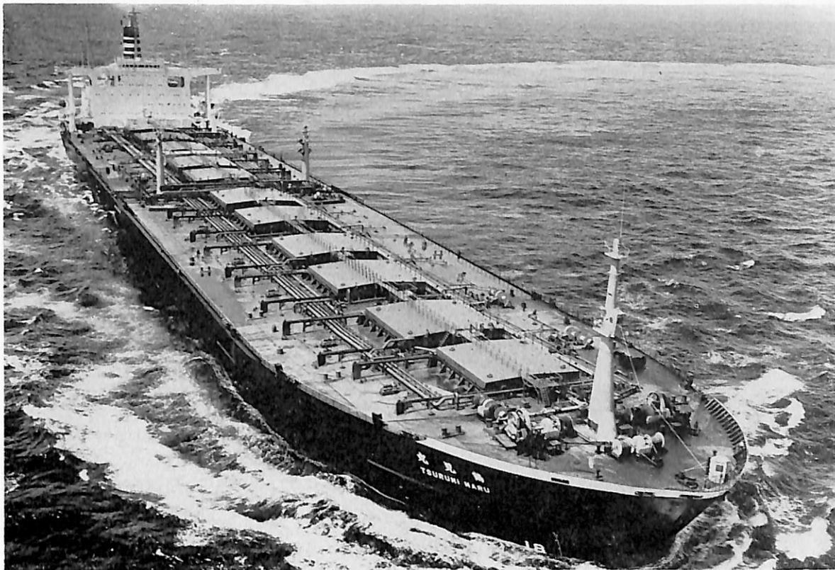
鶴見丸 (鉱石兼油槽船) 船主 日本郵船株式会社・昭和郵船株式会社 造船所 日本鋼管・津造船所 総噸数 116,226.44 噸 純噸数 96,075.24 噸 遠洋 船級 NK 載貨重量 217,275 噸 全長 327.8 m 長(垂) 310.0 m 幅(型) 50.0 m 深(型) 25.5 m 吃水 19.165 m 平甲板船 主機 三菱-衝動-反動式クロスコンパ ウンド型タービン MS-32型 (ロックドトレイン型 2段減速装置付) 1基 出力 30,000 PS×85 RPM 燃料消費量 147.4 t/d 航続距離 20,900 海里 速力 15.3ノット 貨油倉 260,438.8 m 3 燃料油倉 10,992.6 m 3 清水倉 910.7 m 3 乗員 36名 工期 46-9-10, 47-1-26, 47-4-20
