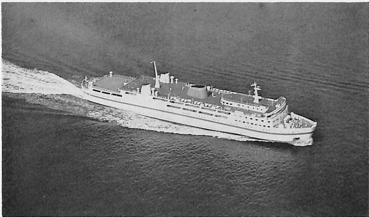
グリーンアロー (自動車航送客船) 船主 広島グリーンフェリー株式会社 造船所 株式会社 神田造船所 総噸数 5,937.84 噸 純噸数 3,129.33 噸 載貨重量 2,128.84 噸 全長 135.26 m 長(垂) 125.00 m 幅(型) 22.00 m 深(型) 7.50 m 吃水 5.29 m 満載排水量 6,929.75 噸 全通船楼甲板型 主機 川崎 MAN V 8 V 40/54 型ディーゼル機関 2 基 出力 2×8,010 PS×430/240 RPM 燃料消費量 150 g/ps/h 航続距離 1,800 海里 速力 21.5 ノット 燃料油倉 C 227.74 m 3 A 27.13 m 3 清水倉 334.89 m 3 乗員 47 名 工期 46-8-26, 46-12-3, 47-4-15 設備 可変ピッチプロペラ, レーダー, 音測, ジャイロ, 船舶電話, ハウスラスタ
