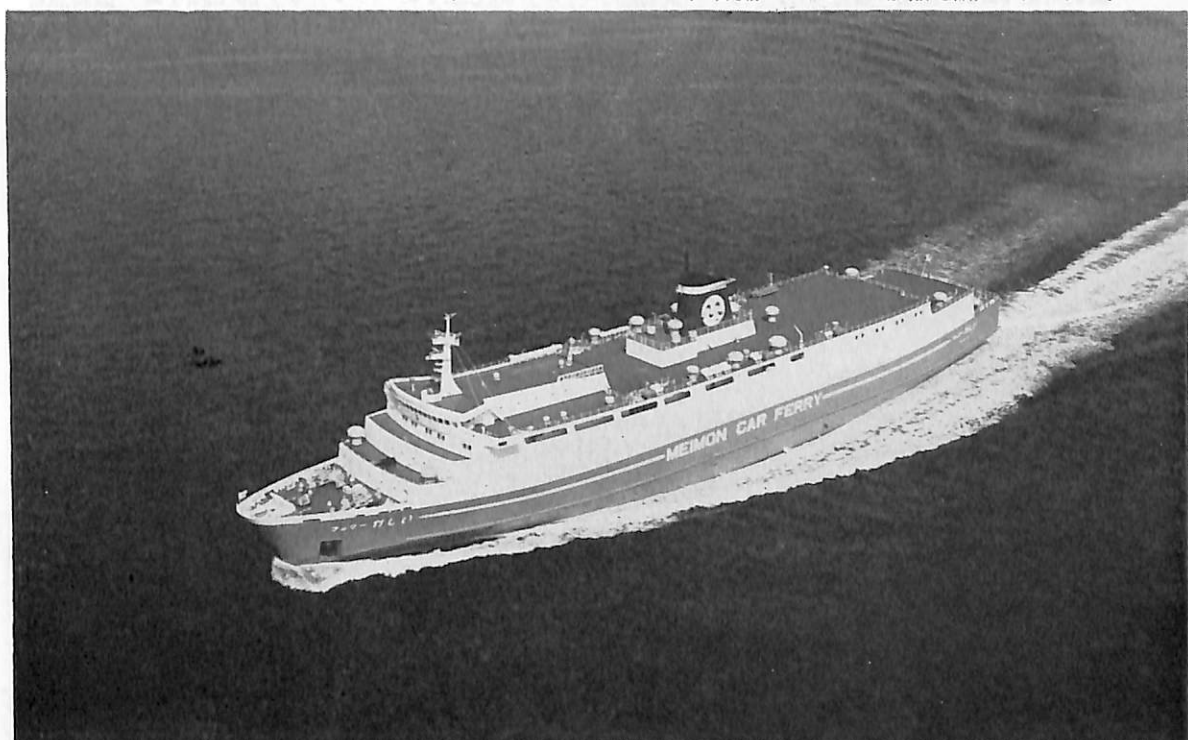
フェリー かしい (自動車航送客船) 船主 名門カーフェリー株式会社 造船所 林兼造船・下関造船所 総噸数 6,496.46 噸 純噸数 2,510.66 噸 載貨重量 2,853.01 噸 全長 140.85 m 長(垂) 128.00 m 幅(型) 22.40 m 深(型) 8.00 m 吃水 5.619 m 満載排水量 8,546.10 噸 平甲板船機関中央 主機 三菱 MAN V 9 V 40/54 型 ディーゼル機関 2 基 出力 2×8,500 PS×406.7 RPM 燃料消費量 53.55 t/d 航続距離 約 2,450 海里 速力 21.5 ノット 燃料油倉 417.14 m 3 清水倉 248.27 m 3 旅客 468 名(ドライバーを含む) 乗員 55 名 工期 46-10 -23, 47-1-21, 47-4-22 設備 フィンスタビライザー 最大揚力 30 tons, ハウスラスター 公称推力 9.4 tons, 船内ランプウエイ 4.00 m×28.93 m, ハウバイザー 非水密跳ね上げ式
