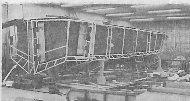
第5図 13m 交通艇のFRP製メス型
