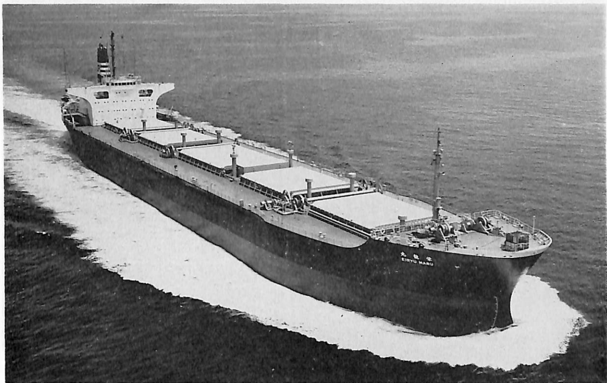
栄 龍 丸 (ばら積貨物船) 船主 太平洋汽船株式会社 造船所 佐世保重工業・佐世保造船所 全長 188.00 m 長(垂) 180.00 m 幅(型) 30.00 m 深(型) 13.50 m 吃水 9.15 m 総噸数 19,924.86 噸 載貨重量 32,875 噸 速力(試) 16.00 ノット 主機 IHI スルザー 7RND 68 型ディーゼル機関 1 基 出力(最 大) 10,500 PS 船級 NK 工期 46-8, 47-2, 47-6-1 設備 M0 取得船, 機関室内の排油処理の焼却 炉装置
