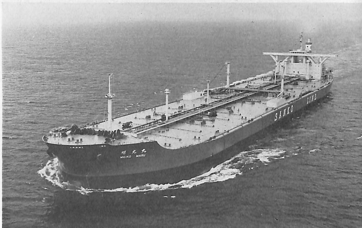
明 光 丸 (油 槽 船) 船 主 三 光 汽 船 株 式 会 社 造 船 所 三 菱 重 工 業 ・ 長 崎 造 船 所 総噸数 117,575.22 噸 純噸数 88,345.99 噸 遠洋 船級 NK 載貨重量 237,758 噸 全長 321.82 m 長(垂) 304.00 m 幅(型) 52.40 m 深(型) 25.70 m 吃水 19.887 m 船首楼付平甲板船 主機 三菱二段減速装置付船 用タービン1基 出力 34,000 PS×90 RPM 燃料消費量 166.5 t/d 航続距離 16,000 海里 速力 15.8ノット 貨 油倉 289,267.3 m 3 燃料油倉 8,586.3 m 3 清水倉 760.1 m 3 乗員 39名 工期 46-9-11, 47-1-22, 47-5-17 同型船 新光丸 設備 イナートガス装置
