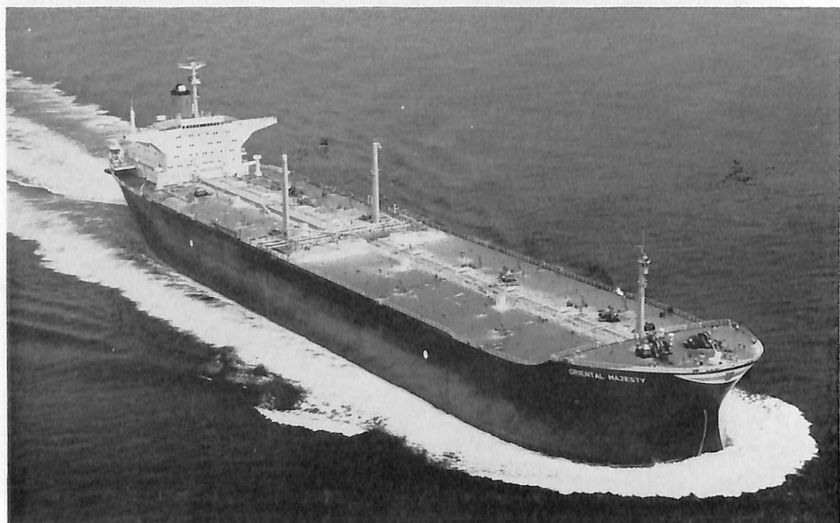
ORIENTAL MAJESTY (油 槽 船) 船 主 Pacific Overseas Tanker Service In. (リベリア) 造 船 所 住友重機械工業・浦賀造船所 長(垂) 258.00 m 幅(型) 44.00 m 深(型) 22.90 m 吃水 16.70 m 総噸数 65,149.75 噸 載貨重量 136,113 噸 速力(航) 15.1ノット 主機 住友スルザー9RND90型ディーゼル機関 1基 出力 26,100 PS×112 RPM 船級 AB 工期 46-11-22, 47-2-14, 47-6-7
