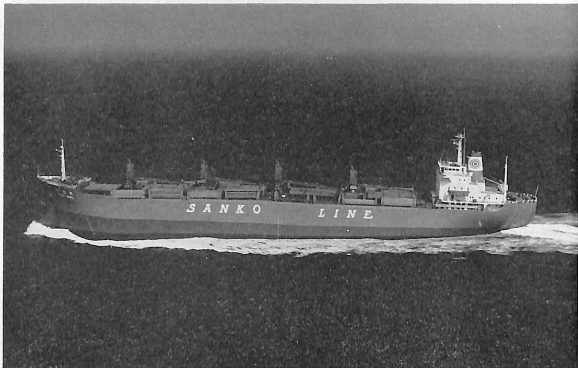
菱 光 丸 (自動車兼ばら積貨物船) 船主 三光汽船株式会社 造船所 佐野安船渠株式会社 総噸数 23,411.91 噸 遠洋 船級 NK 載貨重量 38,082 噸 全長 180.64 m 長(垂) 170.00 m 幅(型) 27.60 m 深(型) 17.00 m 吃水 12.00 m 凹甲板型 主機 住友スルザー 7 RND 76 型ディーゼル機関 1 基 出力(最大) 14,000 PS×122 RPM 航続距離 17,500 海里 速力 15.1 ノット 貨物倉(ペール) 41,011.8 m 3 (グリーン) 42,254.8 m 3 自動車搭載数 ギャランクラス 2,172 台 乗員 37 名 工期 47-1-14, 47-3-18, 47-5-29 設備 カーデッキ: ホイスタブルサイドデッキ 5 層, 同エンドデッキ 7 層, センターポンツーンデッキ 8 層
