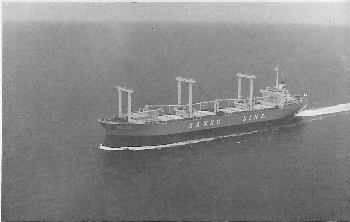
ないる丸(貨物船) 船主 東光商船株式会社 造船所 株式会社 金指造船所 総噸数 19,937.76 噸 純噸数 12,932.81 噸 遠洋 船級 NK 載貨重量 32,678 噸 全長 182.00 m 長(垂) 170.00 m 幅(型) 27.00 m 深(型) 15.20 m 吃水 10.823 m 満載排水量 40,727 噸 凹甲板船 主機 三井 B&W 6 K 74 EF 型ディーゼル機関 1 基 出力 10,600 PS×120 RPM 燃料消費量 156 g/ps.h 航続距離 15,000 海里 速力 14.8 ノット 貨物倉(ベール) 39,819 m 3 (グレーン) 41,476 m 3 燃料油倉 A 211 m 3 C 2,069 m 3 清水倉 535 m 3 乗員 38 名 工期 46-10-7, 47-2-14, 47-5-30
