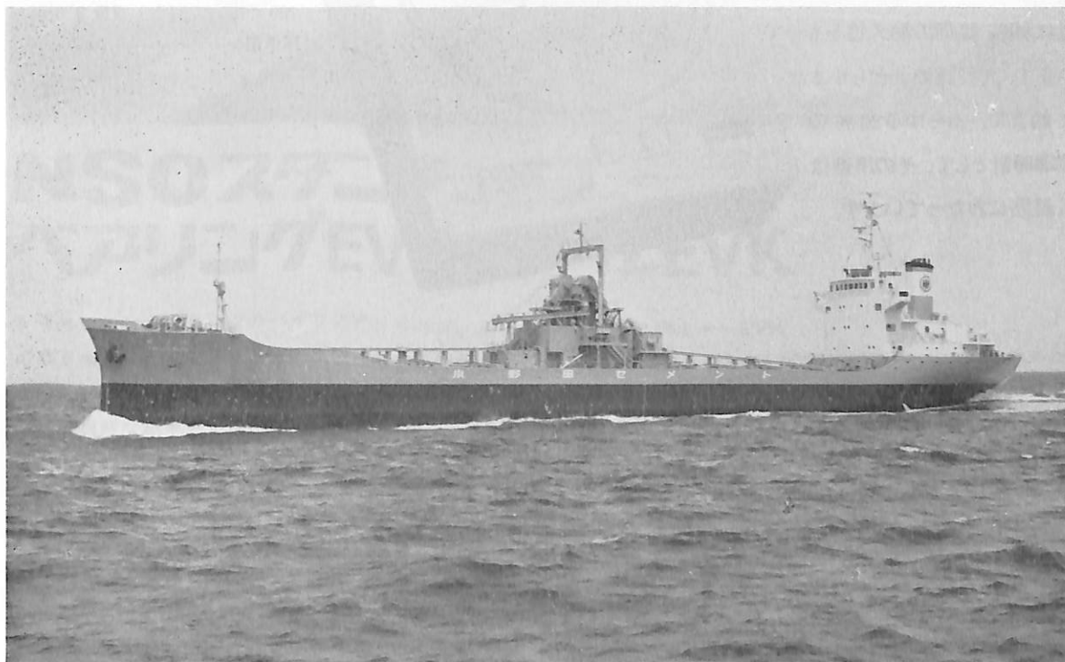
琢洋丸 (セメント運搬船) 船主 宝洋海運産業株式会社 造船所 日本海重工業株式会社 総噸数 3,518.21 噸 純噸数 1,768.20 噸 沿海 船級 NK 載貨重量 6,267 噸 全長 110.15 m 長(垂) 104.00 m 幅(型) 15.00 m 深(型) 8.40 m 吃水 6.755 m 満載排水量 8,155 噸 凹甲板船尾機関型 主機 ダイハツ 8 PS TcM-30" ディーゼル機関 2 基 1 軸 出力 2×1,130 PS×189 RPM 燃料消費量 10.1 t/d 航続距離 3,230 海里 速力 12.23 ノット 貨物倉(グレーン) 5,177 m 3 燃料油倉 A 33.4 m 3 B 119.4 m 3 清水倉 76.4 m 3 乗員 20 名(その他の者 3 名含む) 工期 46-12-18, 47-3-8, 47-6-29 設備 積込能力 1,000 kt/h 荷揚 能力 400 kt/h
