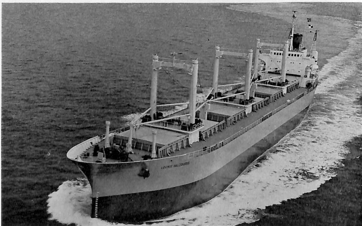
LEONIS HALCOUSSIS (貨物船) 船主 Olympiakas Compania Naviera S.A. (ギリシヤ) 造船所 石川島播磨重工業・東京工場 総噸数 8,978.22 噸 純噸数 6,231.00 噸 遠洋 船級 LR 載貨重量 15,154 噸 全長 143.42 m 長(垂) 134.112 m 幅(型) 19.812 m 深(型) 12.344 m 吃水 9.042 m 平甲板船 主機 IHI-S.E.M.T. ビールスチック 1 基 出力 4,540 PS×480 RPM 燃料消費量 18.2 t/d 航続距離 19,000 海里 速力 13.6 ノット 貨物倉(ペール) 18,988.7 m 3 (グリーン) 20,140.8 m 3 燃料油倉 1,356.3 m 3 清水倉 174.2 m 3 乗員 29 名 工期 46-11-30, 47-2-29, 47-5-24
