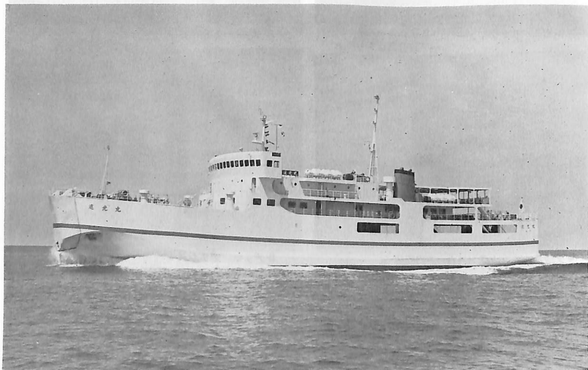
進光丸 (自動車航送客船) 船主 周防灘航送船株式会社 造船所 三菱重工業・下関造船所 総噸数 1,253.73 噸 純噸数 406.80 噸 限定沿海 載貨重量 620.6 噸 全長 71.35 m 長(垂) 65.00 m 幅(型) 13.40/12.80 m 深(型) 4.80 m 吃水(型) 3.65 m 満載排水量 1,876.0 噸 一層甲板型 主機 ダイハツ 6 OSM- 32 型ディーゼル機関 2 基 出力 2 \times 1,700 \text{ PS} \times 570/249 \text{ RPM} 燃料消費量 約 14 t/d 航続距離 1,900 海里 速力 約 14.9 ノット 旅客 585 名 自動車 大型車 19 台 乗用車 11 台 燃料油倉 89.64 m 3 清水倉 61.08 m 3 乗員 40 名 工期 46-12-21, 47-4-28, 47-6-26 設備 パウスラスタ (三菱 KAMEWA PS 300/3 S 可変ピ ッチ式), トルクヒンジ式船首扉
