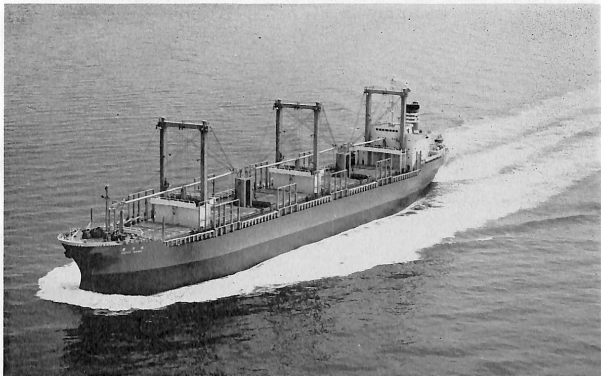
豊 洋 丸 (ばら積貨物船) 船主 太平洋海運株式会社 造船所 笠戸船渠株式会社・笠戸造船所 総噸数 19,830.28 噸 純噸数 12,692.85 噸 遠洋 船級 NK 載貨重量 33,867 噸 全長 185.00 m 長(垂) 175.00 m 幅(型) 27.00 m 深(型) 15.30 m 吃水 11.013 m 満載排水量 42,174 噸 一層甲板(トップサイドタンク付) 凹甲板船 主機 IHI-スルザー 7 RND 68 型ディーゼル機関 1 基 出力 9,800 PS×142.1 RPM 航続距離 15,700 海里 速力 14.5 ノット 貨物倉(ベール) 40,867.0 m 3 (グリーン) 41,962.4 m 3 燃料油倉 1,890.0 m 3 清水倉 730.91 m 3 乗員 33 名 工期 49-12-10, 47-2-21, 47-7-1, "M0" 取得船
