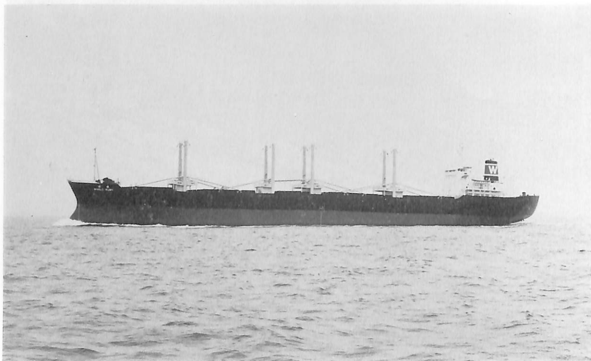
WORLD RUBY (ばら積貨物船) 船主 Liberian Ruby Transports, Inc. (リベリア) 造船所 株式会社 大阪造船所 総噸数 19,654.24 噸 純噸数 13,871 噸 遠洋 船級 AB 載貨重量 33,644 噸 全長 185.50 m 長(垂) 175.00 m 幅(型) 26.00 m 深(型) 15.50 m 吃水 11.151 m 満載排水量 41,748 噸 凹甲板型 主機 IHI-スルザー7 RND 68型ディーゼル機関1基 出力 10,395 PS×144.8 RPM 燃料消費量 42.03 t/d 航続距離 約 16,110 海里 速力 14.6 ノット 貨物倉(ベール) 41,242 m 3 (グリーン) 44,735 m 3 燃料油倉 2,164.9 m 3 清水倉 432.4 m 3 乗員 50 名 工期 46-12-22, 47-3-23, 47-6-13 同型船 EASTER JADE
