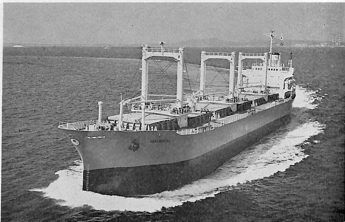
AQUAMARINE (貨物船) 船主 Gerania II Shipping Company S.A. (ギリシヤ) 造船所 石川島播磨重工業・東京工場 総噸数 9,856.29 噸 純噸数 6,250 噸 遠洋 船級 AB 載貨重量 15,174 噸 全長 143.402 m 長(垂) 134.112 m 幅(型) 19.812 m 深(型) 12.344 m 吃水 9.035 m 平甲板型 主機 IHI-S.E.M.T. ビールスチックディーゼル機 1 基 出力 4,500 PS×480 RPM 燃料消費量 18,240 t/d 航続距離 19,000 海里 速力 13.6 ノット 貨物倉(ペール) 18,488.7 m 3 (グリーン) 20,140.8 m 3 燃料油倉 1,356.3 m 3 清水倉 174.2 m 3 乗員 31 名 工期 46-9-10, 46-11-29, 47-3-14
