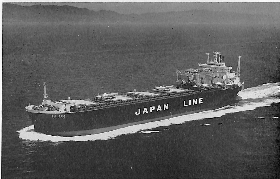
第二十条丸 (チップ運搬船) 船主 日新汽船株式会社, ジャパンライン株式会社 造船所 三井造船・藤永田造船所 全長 182.60 m 長(垂) 174.00 m 幅(型) 27.80 m 深(型) 18.50 m 吃水 10.00 m 総噸数 26,088.82 噸 載貨重量 31,179 噸 貨物倉(ベール) 56,296 m 3 (グレーン) 59,871 m 3 速力(試) 16.7 ノット 主機 三井 B&W 6 K 74 EF 型ディーゼル機関 1 基 出力(連続最大) 11,600 PS×124 RPM (常用) 9,900 PS×117.5 RPM 乗員 27 名 船級 NK 工期 47-1, 47-3, 47-6-30 設備 250 t/h, 三井-パセコ型ガントリークレーン×2 (10.5 t ジブクレーン付), Mo 取得船
