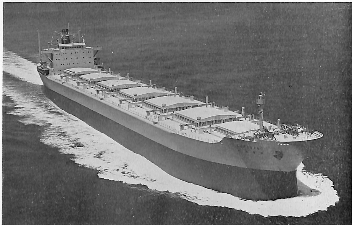
TAKASAGO (ばら積貨物船) 船主 Wilh. Wilhelmsen 系列9社(ノールウェー) 造船所 三菱重工業・神戸造船所 総噸数 36,264.61 噸 純噸数 23,302.43 噸 遠洋 船級 NV 載貨重量 63,479 噸 全長 224.00 m 長(垂) 211.28 m 幅(型) 31.80 m 深(型) 18.35 m 吃水 13.345 m 満載排水量 75,315 噸 船首樓付平甲板船 主機 三菱スルザー7 RND 76型ディーゼル機関1基 出力 12,600 PS×118 RPM 燃料消費量 47.8 t/d 航続距離 約 22,000 海里 速力 14.6 ノット 貨物倉(グリーン) 76,315 m 3 燃料油倉 3,505.1 m 3 清水倉 543.8 m 3 乗員 35 名 工期 46-10-1, 47-2-15, 47-6-14 同型船 TAKAMINE (48-2 竣工予定), TAKACHIHO (38-12 竣工予定) 設備 自動化 "EO" 適用, パラスタック epoxy tar 施工
