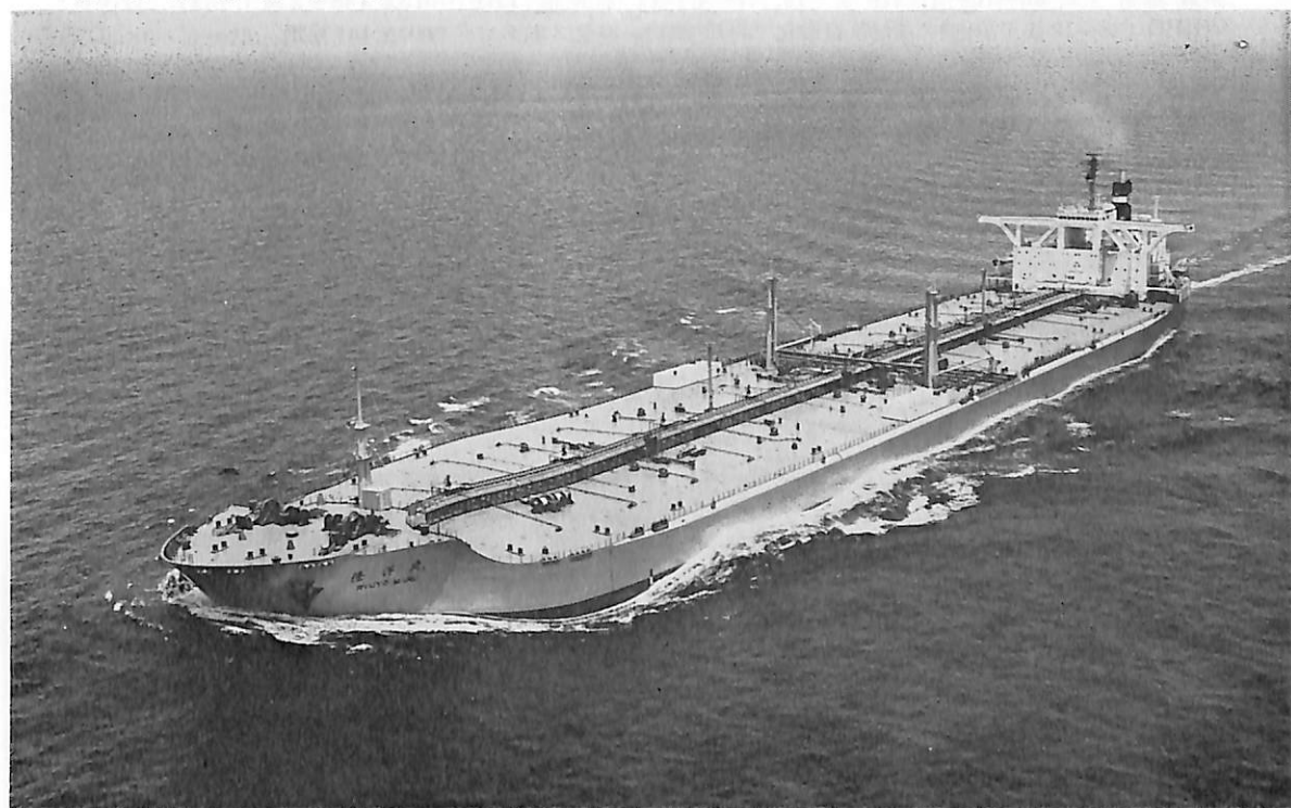
隆 洋 丸 (油槽船) 船主 大洋商船株式会社 造船所 三菱重工業・長崎造船所 総噸数 117,609.40 噸 純噸数 88,065.01 噸 遠洋 船級 NK 載貨重量 237,559 噸 全長 321.82 m 長(垂) 304.00 m 幅(型) 52.40 m 深(型) 25.70 m 吃水 19.85 m 満載排水量 271.391 噸 船首樓付平甲板船 主機 三菱船用パッケージド減速装置付蒸気タービン 1 基 出力 34,000 PS×90 RPM 燃料消費量 約 166.5 t/d 航続 距離 約 16,500 海里 速力 15.8 ノット 貨油倉 289,267.3 m 3 燃料油倉 8,265.5 m 3 清水倉 760.1 m 3 乗員 38 名 工期 46-10-1, 47-2-13, 47-6-15 同型船 新光丸
