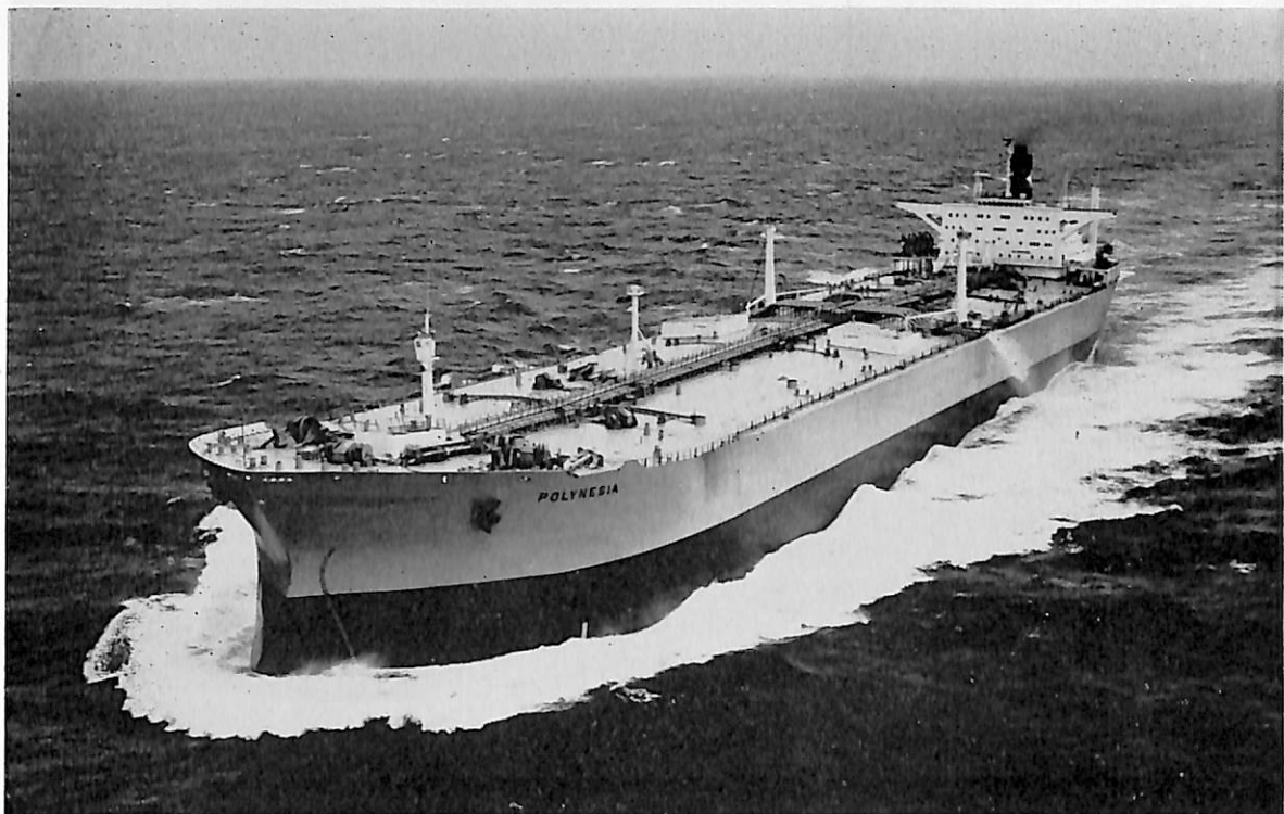
POLYNESIA (油槽船) 船主 Einar Rasmussen (ノールウェー) 造船所 三井造船・千葉造船所 全長 324.182 m 長(垂) 309.982 m 幅(型) 48.768 m 深(型) 25.298 m 吃水 19.622 m 総噸数 112,445.6噸 噸 載貨重量 221,070 噸 貨油倉 267,106 m 3 速力(試) 16.65 ノット 主機 三井 B&W 9 K 98 型ディーゼル 機関 1 基 出力(連続最大) 34,000 PS×103 RPM (常用) 31,500 PS×100 RPM 乗員 43 名 船級 LR 工期 46-9, 47-2, 47-6-15
