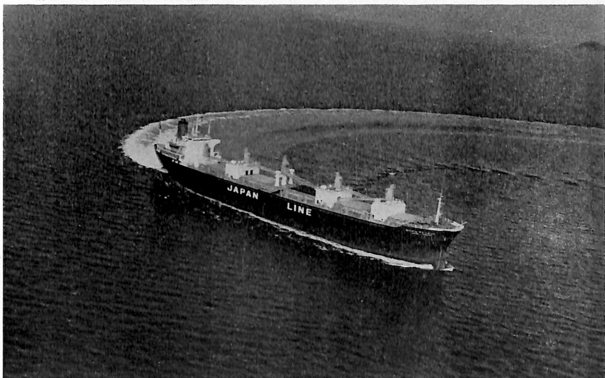
ジャパン チャリオット (自動車兼ばら積貨物船) 船主 ジャパンライン株式会社, 広海汽船株式会社 造船所 常石造船株式会社 総噸数 19,353.46 噸 純噸数 11,865.61 噸 遠洋 船級 NK 載貨重量 29,473 噸 全長 181.71 m 長(垂) 170.00 m 幅(型) 25.40 m 深(型) 15.30 m 吃水 11.023 m 満載排水量 39,011 噸 凹甲板型 主機 IHI-スルザー 7 RND 68 型ディーゼル機関 1 基 出力 9,820 PS×142 RPM 燃料消費量 40.7 t/d 航続距離 18,500 海里 速力 14.9 ノット 貨物倉(ペール) 32,152.5 m 3 (グリーン) 32,710.2 m 3 自動車搭載数 ブルー バード 1,942 台 燃料油倉 F.O 2,575.4 m 3 D.O 229.6 m 3 清水倉 489.2 m 3 乗員 33 名 工期 46-8-11, 46-12-5, 47-2-25 設備 Roll on Roll off 式で自動車運搬, 艙内 7 段の car deck
