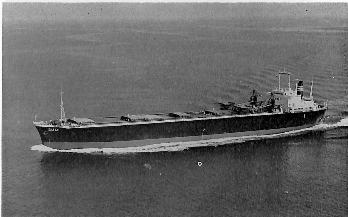
ばびるす丸 (チップ運搬船) 船主 千代田汽船株式会社, 日本郵船株式会社 造船所 日本鋼管・清水造船所 総噸数 19,523.29 噸 純噸数 14,563.15 噸 遠洋 船級 NK 載貨重量 24,317.6 噸 全長 176.00 m 長(垂) 166.00 m 幅(型) 23.7 m 深(型) 17.5 m 吃水 9.728 m 満載排水量 30,427 噸 平甲板型 主機 NKK-S.E. M.T. ピールスタック 16 PC 2 V 型ディーゼル機関 1 基 出力 6,800 PS×493/119 RPM 燃料消費量 152.12 g/ps/h 速力 14.2 ノット 貨物倉(グレーン) 46,547.5 m 3 燃料油倉 1,218.3 m 3 清水倉 438.8 m 3 乗員 31 名 工期 46-12-16, 47-3-27, 47-6-30
