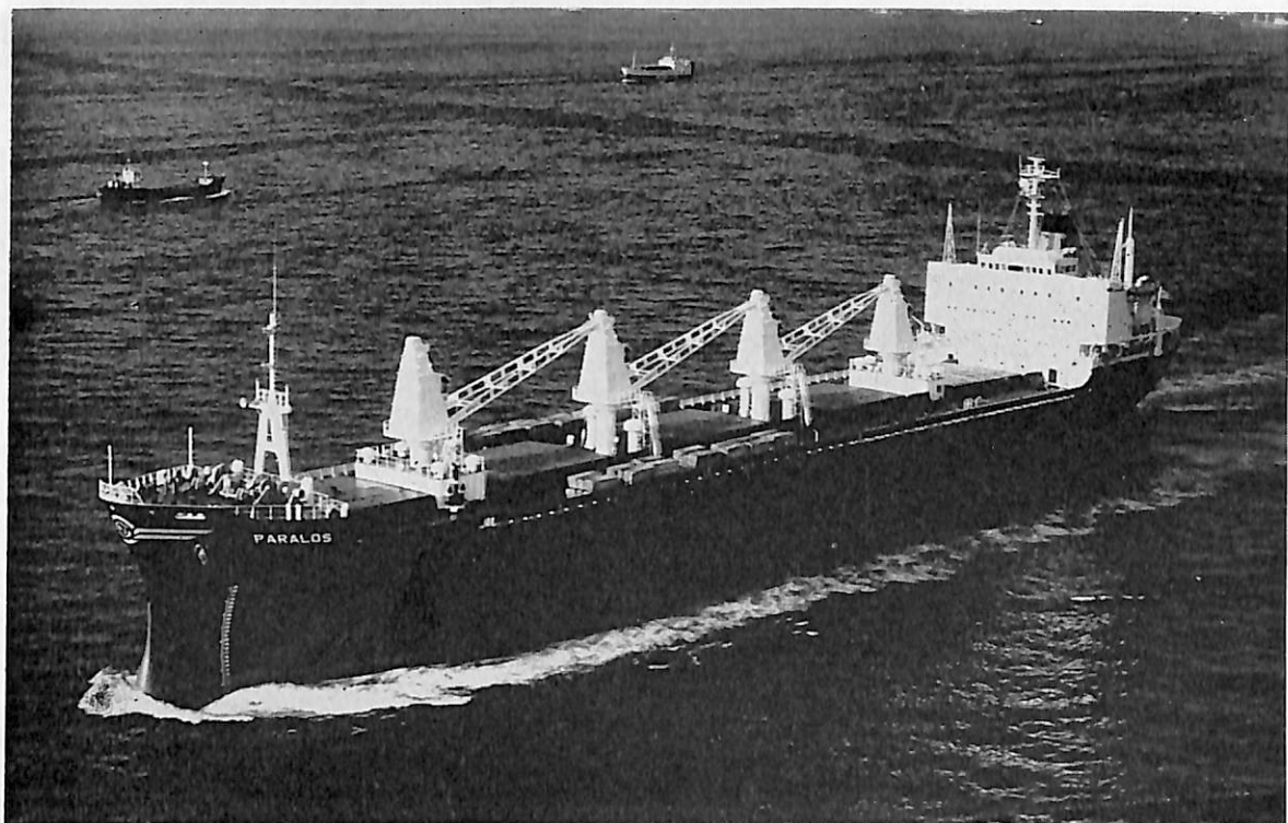
PARALOS (ばら積貨物船) 船主 Transatlantic Investment Corp. (キリシヤ) 造船所 佐野造船株式会社 総噸数 10,878.82 噸 純噸数 7,421 噸 遠洋 船級 AB 載貨重量 17,354 噸 全長 147.50 m 長(垂) 140.00 m 幅(型) 21.50 m 深(型) 12.60 m 吃水 9.25 m 凹甲板船尾機関型 主機 住友スルザー 6 RND 68 型ディーゼル機関 1 基 出力(連続最大) 9,000 PS×137 RPM 航続距離 13,500 海里 速力(試) 18.88 ノット (航) 約 15.1 ノット 汽缶 1200 kg/h×7 kg/cm 2 ×1 貨物倉(ベール) 19,887 m 3 (グリーン) 23,416 m 3 乗員 38 名 工期 47-2-22, 47-4-10, 47-6-14 荷役装置 10 t 型電動油圧式デッキクレーン×4 基
