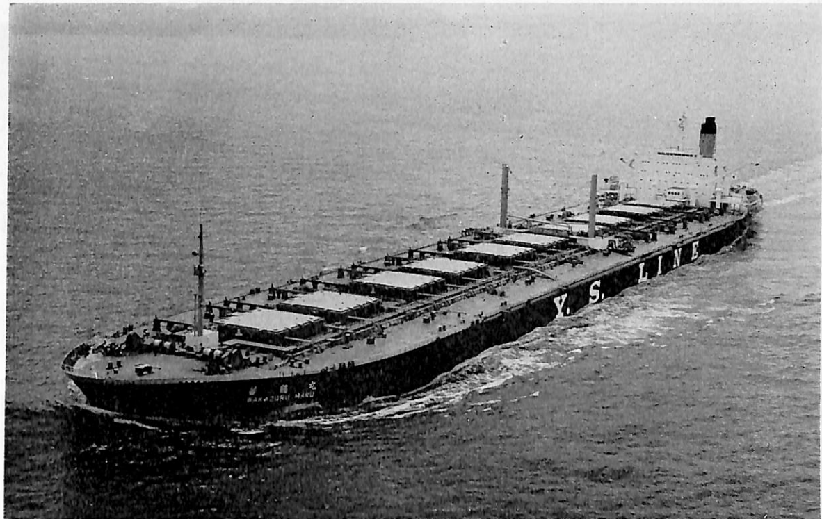
若 鶴 丸 (鉱石兼油槽船) 船主 山下新日本汽船株式会社, 日正汽船株式会社 造船所 日立造船 ・因島工場 総噸数 89,427.63 噸 純噸数 62,626.51 噸 遠洋 船級 NK 載貨重量 165,087 噸 全長 300.00 m 長(垂) 289.00 m 幅(型) 48.00 m 深(型) 23.00 m 吃水 17.12 m 満載排水量 196,527 噸 平甲板船 主機 日 立 B&W 12 K 84 EF 型ディーゼル機関 1 基 出力 26,270 PS×108 RPM 燃料消費量 101.8 t/d 航続距離 26,500 海里 速力 15.55 ノット 貨物倉(鉱石) 92,814.14 m 3 貨油倉 202,307.78 m 3 燃料油倉 7,839.39 m 3 清水倉 1,000.72 m 3 乗員 39 名 工期 46-10-25, 47-2-19, 47-5-12
