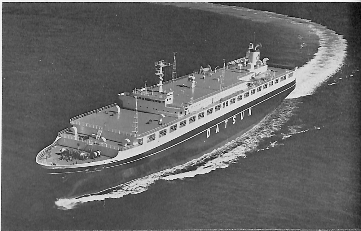
河丸 (自動車運搬船) 船主 日之出汽船株式会社, 昭和海運株式会社 造船所 日立造船・舞鶴工場 総噸数 7,016.11 噸 純噸数 2,949.7 噸 遠洋 船級 NK 載貨重量 9,267 噸 全長 174.50 m 長(垂) 164.00 m 幅(型) 25.40 m 深(型) 8.10 m 吃水 7.20 m 満載排水量 17,086 噸 主機 日立 B&W 9 K 62 型ディーゼル機 関 1 基 出力 10,540 PS×137 RPM 燃料消費量 43.05 t/d 航続距離 14,000 海里 速力 20.29 ノット 自動車積 載数 2,530 台 (22,800 m 3 ) 燃料油倉 1,502.06 m 3 清水倉 610.63 m 3 乗員 32 名 工期 46-11-2, 47- 2 25. 47-6-12
