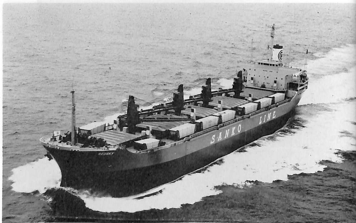
REOSKY (ばら積貨物船) 船主 The Oceanic Freighters Corp.(リベリア) 造船所 住友重機械工業・浦賀造船所 長(垂) 170.00 m 幅(型) 28.40 m 深(型) 15.00 m 吃水 10.13 m 総噸数 18,723.97 噸 載貨重量 33,757 噸 速力 14.8 ノット 主機 住友スルザー 7 RD 76 型ディーゼル機関 1 基 出力 11,200 PS×122 RPM 船級 BV 工期 46-12-27, 47-4-11, 47-6-28 設備: 約 1,000 台の自動車をリフト・オン、オフ方式で積載する設備。トップサイドタンクの一部は穀物専用
