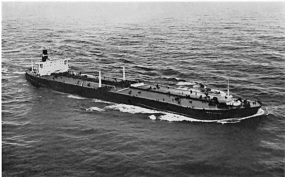
WORLD HORIZON (油槽船) 船主 Bamber Shipping Corp.(リベリア) 造船所 三井造船・千葉造船所 全長 324.182 m 長(垂) 309.982 m 幅(型) 48.768 m 深(型) 25.298 m 吃水 19.622 m 総噸数 102,325.93 噸 載貨重量 224,045 噸 貨油倉 272,241 m 3 速力(試) 16.148 ノット 主機 船用タービン 1 基 出力(連続 最大) 29,000 PS×86.5 RPM 船級 LR 工期 46-11, 47-4, 47-7-24 同型船 WORLD HAPPINESS
