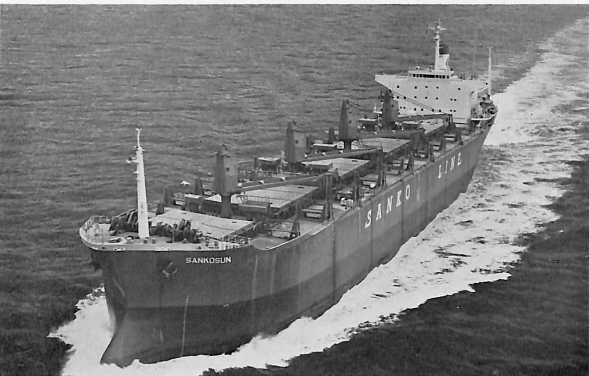
SANKOSUN (自動車兼ばら積貨物船) 船主 Inca Shipping Inc. (リベリア) 造船所 佐野安船渠株式会社 総噸数 20,714.76 噸 遠洋 船級 BV 載貨重量 37,411 噸 全長 180.64 m 長(垂) 170.00 m 幅(型) 27.60 m 深(型) 17.00 m 吃水 12.00 m 凹甲板船尾機関型 主機 住友スルザー 7RND 76 型ディーゼル機関 1 基 出力 (最大) 14,000 PS×122 RPM 航統距離 17,500 海里 速力(最大) 17.58 ノット (航海) 15.1 ノット 汽缶(補) 1,500 kg/h×7 kg/cm 2 G×1 發電機 500 KVA×AC 450 V×3 貨物倉(ペール) 41,012 m 3 (グレーン) 42,255 m 3 自動車搭載台数 (コロナクラス) 2,172 台 (17,000 m 3 ) 乗員 39 名 工期 47-3-18, 47-5-24, 47-7-25
