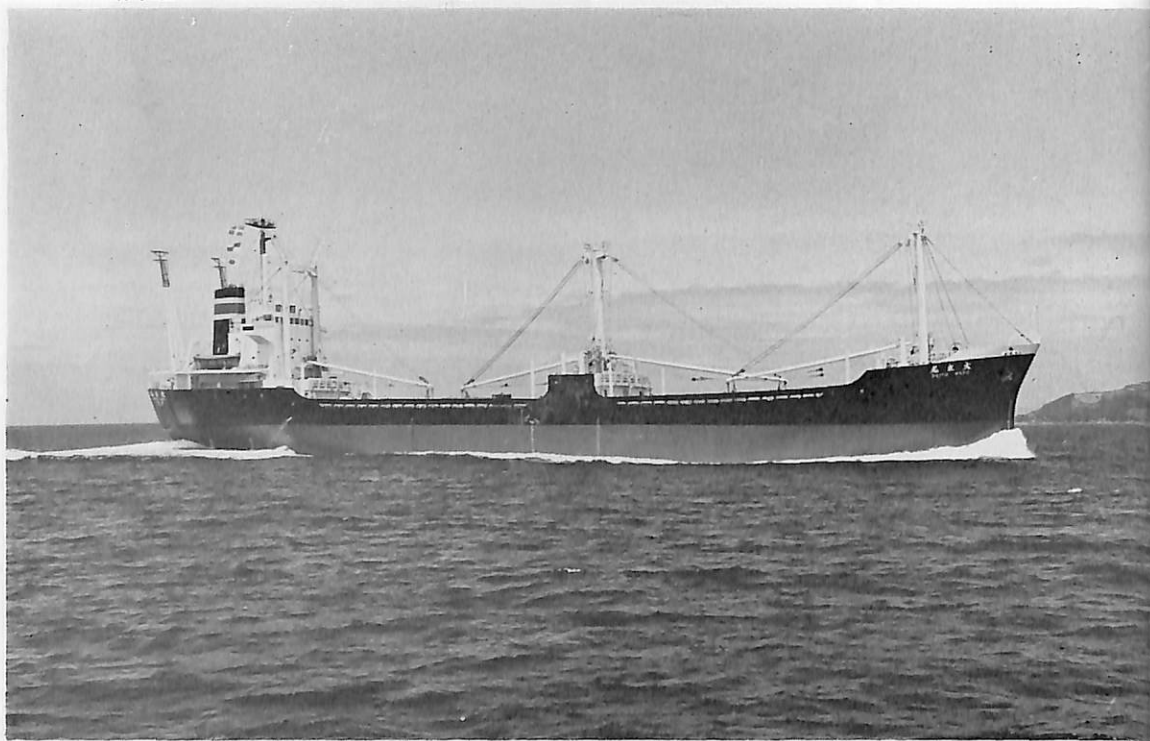
大 東 丸 (木材運搬船) 船主 大東海運株式会社 造船所 株式会社 来島どっく・宇和島工場 総噸数 3,137.88 噸 純噸数 2,115.60 噸 近海 船級 NK 載貨重量 5,975.50 噸 全長 101.10 m 長(垂) 94.0 m 幅(型) 16.0 m 深(型) 8.20 m 吃水 6.830 m 満載排水量 7,830.0 噸 凹甲板船尾機関型 主機 神戸発動機 6 UET 45/75 C 型ディーゼル機関 1 基 出力 3,230 PS×218 RPM 燃料消費量 12.40 t/d 航統距離 9,500 海里 速力 12.50 ノット 貨物倉(ベール) 7,039.63 m 3 (グレーン) 7,408.30 m 3 燃料油倉 503.91 m 3 清水倉 396.73 m 3 乗員 23 名 工期 47-2-28, 47-4-2, 47-7-11
