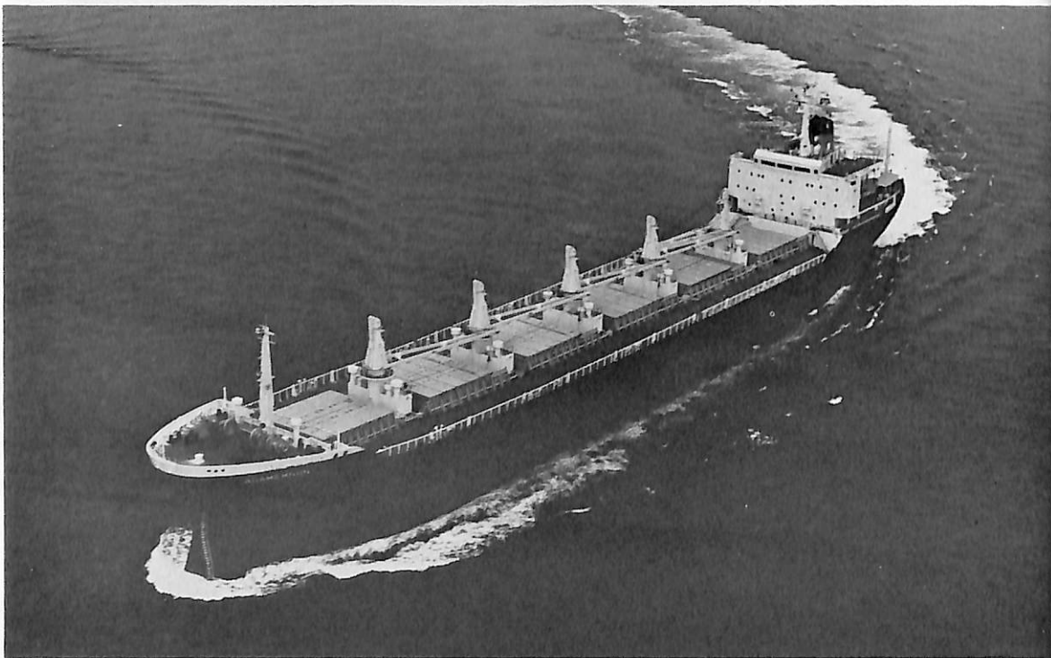
AGAMEMNON (ばら積貨物船) 船主 Elder Dempster Lines Ltd (イギリス) 造船所 三井造船・ 藤永田造船所 全長 176.75 m 長(垂) 168.00 m 幅(型) 22.86 m 深(型) 14.10 m 吃水 10.566 m 総噸数 16,402.35 噸 載貨重量 26,729 噸 貨物倉(グレーン) 36,224 m 3 速力(試) 17.676 ノット(航) 15.25 ノッ ト 主機 三井 B&W 6 K 74 EF 型ディーゼル機関 1 基 出力(定格) 11,600 PS \times 124 RPM (常用) 10,600 PS \times 120 RPM 乗員 38 名 船級 AB 工期 47-1, 47-4, 47-7-14 設備 荷役用 8 トンデッキクレーン 5 台
