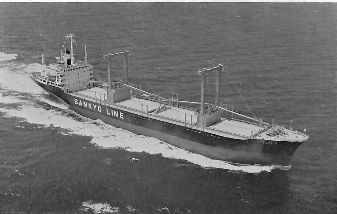
協寿丸 (貨物船) 船主 三協海運株式会社 造船所 三菱重工業・下関造船所 総噸数 12,174.51 噸 純噸数 7,209.97 噸 遠洋 船級 NK 載貨重量 19,094 噸 全長 160.12 m 長(垂) 148.00 m 幅(型) 23.00 m 深(型) 12.46 m 吃水 9.466 m 満載排水量 24,894 噸 凹甲板型 主機 三菱 7 UEC 65/135 C 型ディーゼル機関 1 基 出力 8,190 PS×140 RPM 燃料消費量 30.5 t/d 航続距離 16,000 海里 速力 15.0 ノット 汽缶 コクラン 1,200 kg/h, 7 kg/cm 2 ×1 発電機 AC 450×625 KVA(740 PS)×2 貨物倉(ベール) 22,546.7 m 3 (グリーン) 23,437.4 m 3 燃料油倉 1,718 m 3 清水倉 497 m 3 乗員 30 名 工期 46-10-16, 47-3-18, 47-7-5
