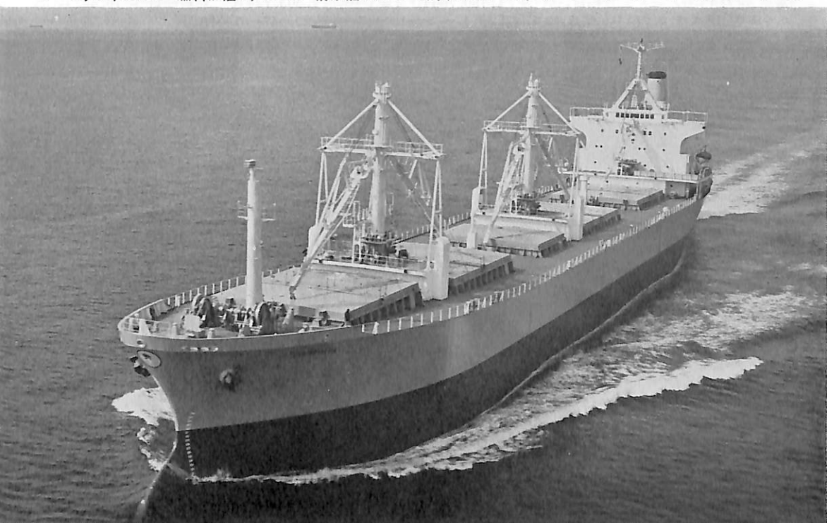
APOLLODORUS (貨物船) 船主 Pelineon Shipping Company S.A. (リベリア) 造船所 石川島播磨重工業 ・東京工場 総噸数 13,121 噸 純噸数 9,392 噸 遠洋 船級 AB 載貨重量 22,591 噸 全長 164.33 m 長(垂) 155.448 m 幅(型) 22.86 m 深(型) 13.56 m 吃水 9.848 m 主機 IHI-ビールスチック16PC-2V型ディーゼル 機関1基 出力 7,200 PS×482 RPM 燃料消費量 28.1 t/d 航続距離 15,000 海里 速力 15.0 ノット 貨物倉 (グリーン) 30,454 m 3 自動車積載 692 台 燃料油倉 1,337 m 3 清水倉 201 m 3 乗員 27 名 工期 46-9-25, 46-12-27, 47-3-22
