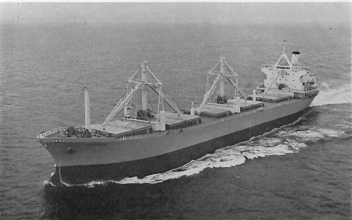
AKADEMOS (貨物船) 船主 Skopos Shipping Company S.A. (リベリア) 造船所 石川島播磨重工業・ 東京工場 総噸数 13,124 噸 純噸数 9,394 噸 遠洋 船級 AB 載貨重量 22,589 噸 全長 164.33 m 長(垂) 155.448 m 幅(型) 22.86 m 深(型) 13.56 m 吃水 9.848 m 主機 IHI-ピールスタック16PC-2V型ディーゼ ル機関1基 出力 7,200 PS×482 RPM 燃料消費量 28.1 t/d 航続距離 15,000 海里 速力 15.0ノット 貨物倉 (ベール) 29,507 m 3 (グリーン) 30,454 m 3 自動車積載 692 台 燃料油倉 1,337 m 3 清水倉 210 m 3 乗員 27 名 工期 46-12-18, 47-3-28, 47-7-12
