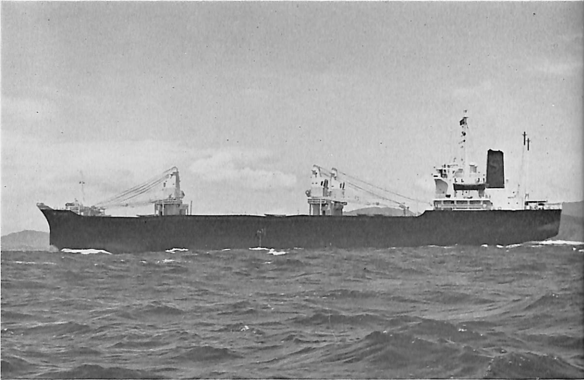
SIAM VENTURE (貨物船) 船主 Marmack Pte., Ltd.(シンガポール) 造船所 四国ドック株式会社 総噸数 7,352.59 噸 純噸数 4,925.75 噸 遠洋 船級 NK 載貨重量 12,126.16 噸 全長 139.67 m 長(垂) 130.00 m 幅(型) 19.20 m 深(型) 11.20 m 吃水 8.269 m 満載排水量 15,614.9 噸 凹甲板型 主機 IHI-SEMT ヲールスチック 14 PC-2 V 型ディーゼル機関 1 基 出力 6,310 PS×493 RPM 燃料消費量 24.4 t/d 航続距離 14,650 海里 速力 14.10 ノット 貨物倉(ベール) 15,403 m 3 (グレーン) 15,960 m 3 燃料油倉 A 146.9 m 3 C 1,155.9 m 3 清水倉 568.9 m 3 乗員 36 名 工期 47-2-15, 47-4-11, 47-7-31
