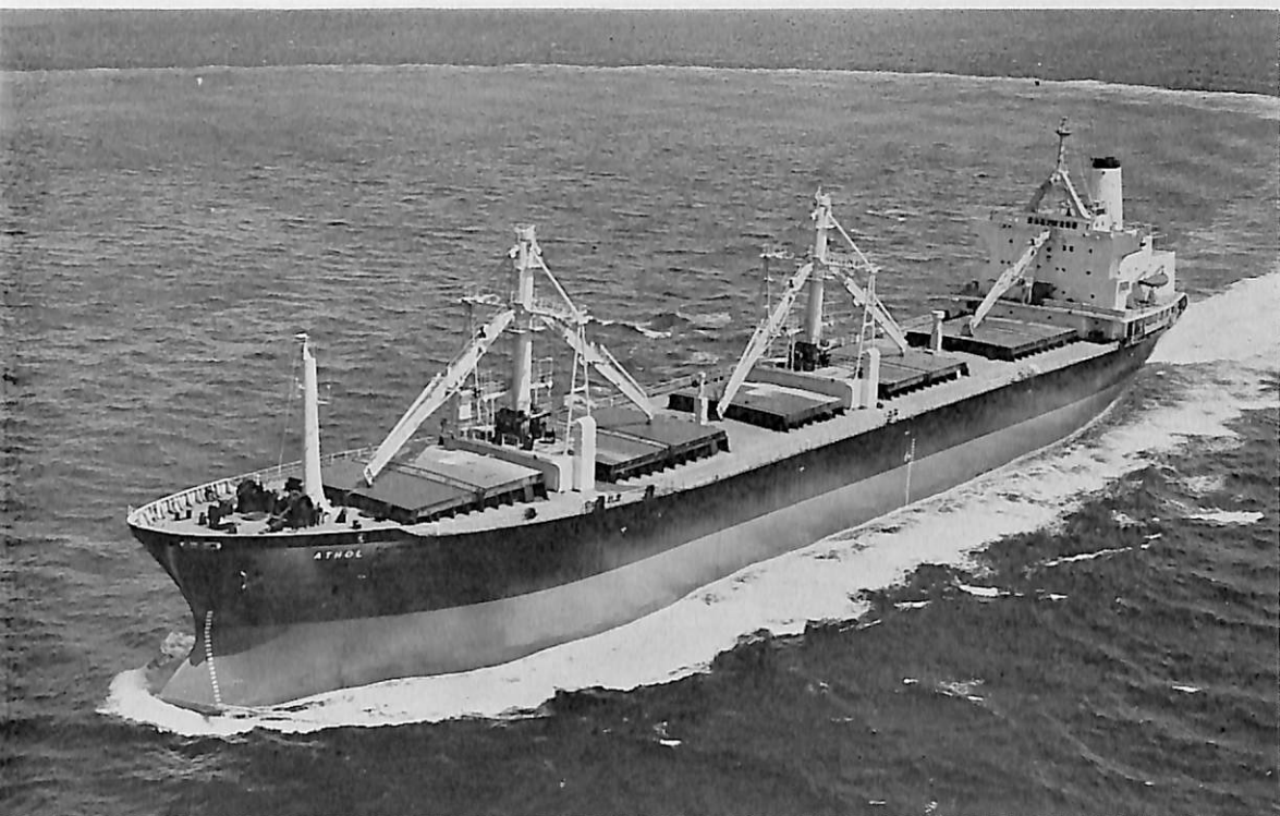
ATHOL (貨物船) 船主 Gramos Shipping Company S.A (リベリア) 造船所 石川島播磨重工業・東京工場 総噸数 13,124 噸 純噸数 9,394 噸 遠洋 船級 AB 載貨重量 22,226 噸 全長 164.33 m 長(垂) 155.448 m 幅(型) 22.86 m 深(型) 13.56 m 吃水 9.848 m 主機 IHI-ピールスタック16PC-2V型ディーゼル機関1基 出力 7,200 PS×482 RPM 燃料消費量 28.1 t/d 航続距離 15,000 海里 速力 15.0ノット 貨物倉(グリーン) 30,454 m 3 自動車積載 547 台 燃料油倉 1,337 m 3 清水倉 210 m 3 乗員 27 名 工期 46-12-13, 47-2-15, 47-6-8
