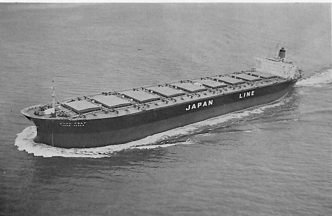
ジャパンアカシア (ばら積貨物船) 船主 ジャパンライン株式会社 造船所 三菱重工業・広島造船所 総噸数 68,203.06 噸 純噸数 45,133.03 噸 遠洋 船級 NK 載貨重量 122,482 噸 全長 261.00m 長(垂) 247.00m 幅(型) 40.60 m 深(型) 24.00 m 吃水 16.831 m 満載排水量 143,482 噸 主機 三菱スルザー9 RND 90 型ディーゼル機関 1 基 出力 23,490 PS×118 RPM 燃料消費量 88.0 t/d 航続距離 27,000 海里 速力 15.6 ノット 汽缶 コクラン 2,000 kg/h×1 発電機 AC 450 60 Hz 937.5 KVA×3 貨物倉(グリーン) 140,206.6 m 3 燃料油倉 7,299.2 m 3 清水倉 592.5 m 3 乗員 33 名 工期 47-1-15, 47-3-28, 47-7-27,
