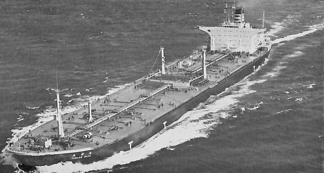
玉野丸 (油槽船) 船主 日本郵船株式会社 造船所 三井造船・玉野造船所 全長 257.00 m 長(垂) 246.00 m 幅(型) 39.40 m 深(型) 16.915 m 吃水 16.915 m 総噸数 62,027.56 噸 載貨重量 117,910 噸 貨油倉 143,832.3 m 3 速力(試) 16.43 ノット 主機 三井 B&W 9K 84 EF 型ディー ゼル機関1基 出力(連続最大) 23,000 PS×144 RPM 船級 NK 工期 47-1, 47-4, 47-7-28 設備 イナートガス装置。荷役制御として、貨物油弁、イナートガス操作、タンク内の油面や圧力および本船 の吃水の読み取りを行なう
