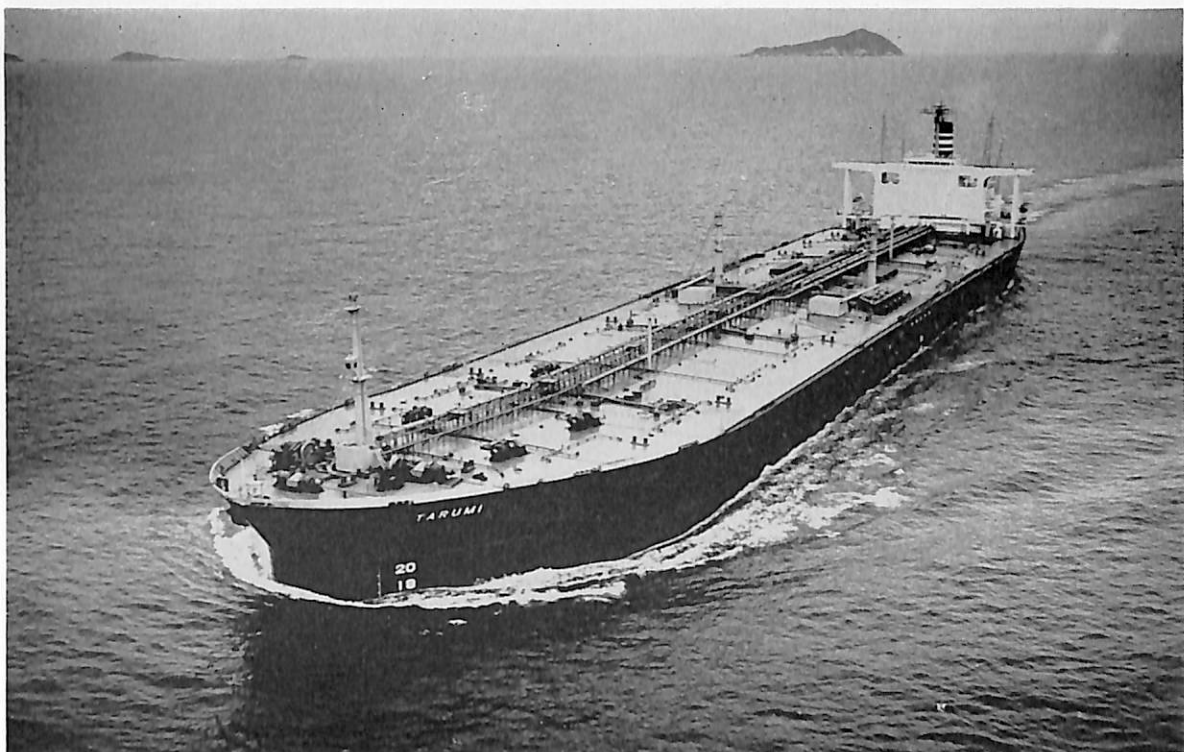
垂水丸 (油槽船) 船主 日本郵船株式会社 造船所 日本鋼管・津造船所 総噸数 129,382.33 噸 純噸数 111,178 噸 遠洋 船級 NK 載貨重量 262,041 噸 全長 331.500 m 長(垂) 314.000 m 幅(型) 54.800 m 深(型) 26.400 m 吃水 20.588 m 平甲板船 主機 IHI ロックドトレイン型 2 段 減速装置付 衝動式 クロスコンパウンド 蒸気タービン 1 基 出力 36,000 PS×85 RPM 燃料消費量 177.8 t/d 航 続距離 18,830 海里 速力 15.8 ノット 貨油倉 321,648.6 m 3 燃料油倉 9,777.5 m 3 清水倉 841.1 m 3 乗員 32 名 工期 46-11-24, 47-3-25, 47-6-29
