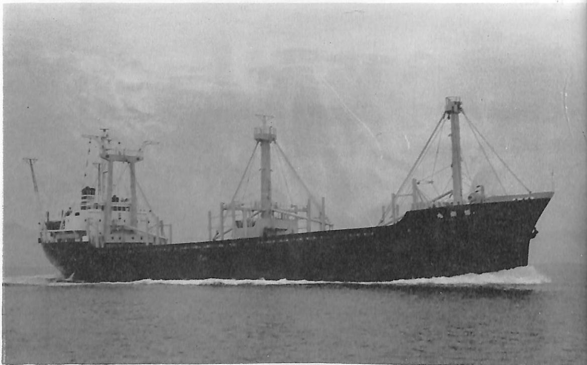
博栄丸 (貨物船) 船主 今治船舶有限公司, 三井物産株式会社 造船所 今治造船株式会社 総噸数 3,669.12 噸 純噸数 2,449.00 噸 近海 船級 NK 載貨重量 6,552.90 噸 全長 105.31 m 長(垂) 98.60 m 幅(型) 16.33 m 深(型) 8.40 m 吃水 6.837 m 満載排水量 8,566.00 噸 ウェル甲板型 主機 阪神内燃機 6 LU 50 A 型ディーゼル機関 1 基 出力 3,230 PS×232 RPM 燃料消費量 13.128 t/d 航続距離 11,271 海里 速 力 12.75 ノット 貨物倉(ベール) 8,018.912 m 3 (グレーン) 8,421.483 m 3 燃料油倉 586.87 m 3 清水倉 421.55 m 3 乗員 25 名 工期 47-5-4, 46-5-14, 47-6-20
