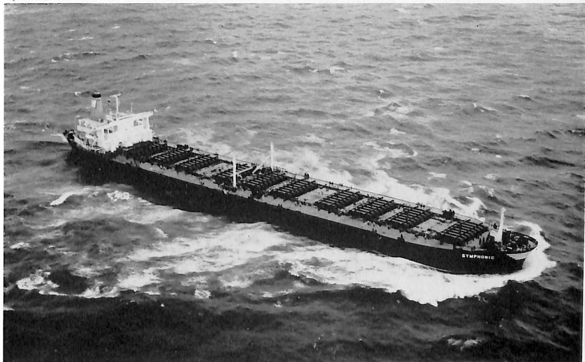
SYMPHONIC (鉾石兼ばら積貨物船) 船主 Westwind Shipping Company S.A.(リベリア) 造船所 石川島 播磨重工・相生工場 総噸数 70,507.73 噸 純噸数 53,341 噸 遠洋 船級 AB 載貨重量 150,119 噸 全長 291.00 m 長(垂) 278.80 m 幅(型) 44.50 m 深(型) 24.50 m 吃水 55'-10 3 / 8 " 主機 IHI-船用タービン1基 出力 24,400 PS×80 RPM 燃料消費量 119.1 t/d 航続距離 20,500 海里 速力 15.7 ノット 貨物倉(グリーン) 168,592.4 m 3 貨油倉 172,429.4 m 3 燃料油倉 7,414.7 m 3 清水倉 63.2 m 3 乗員 47 名 工期 46-11, 47- 2, 47-7
