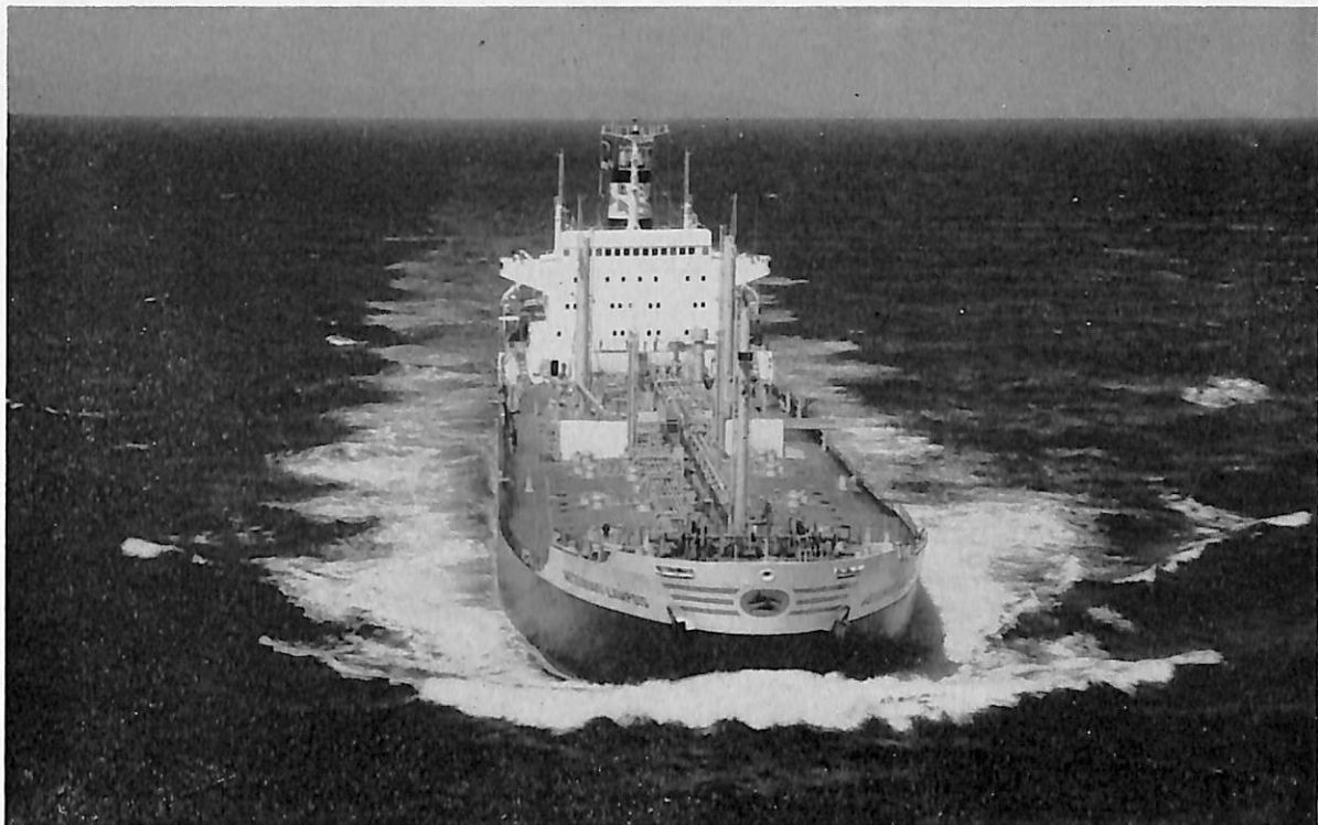
MESSINIAKI LAMPISIS (油槽船) 船主 Inperio Harilimo Navigasion S.A. (ギリシヤ) 造船所 石川島播磨重工・相生工場 総噸数 17,717.75 噸 純噸数 12,298.94 噸 遠洋 船級 LR 載貨重量 30,293 噸 全長 170.608 m 長(垂) 162.00 m 幅(型) 26.00 m 深(型) 14.35 m 吃水 11.006 m 凹甲板型 主機 IHI-スルザー 7 RND 68 型ディーゼル機関 1 基 出力(最大) 115,550 PS×150 RPM (常用) 10,400 PS×114.8 RPM 燃料消費量 36.8 t/d 航続距離 23,600 海里 速力(試) 16.50 ノット (航) 15.75 ノット 貨油倉 3,728.9 m 3 燃料油倉 2,728.9 m 3 清水倉 481.0 m 3 乗員 41 名 工期 46-7, 46-11, 47-3
