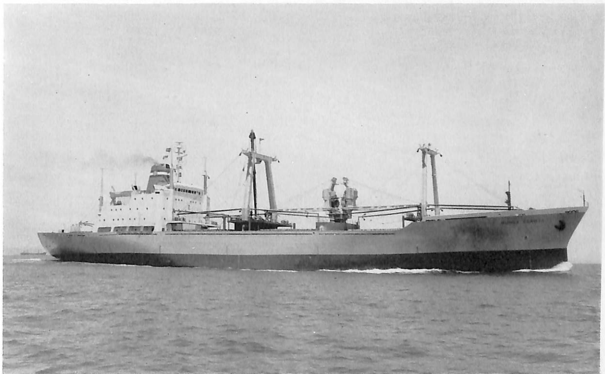
BUNGA SEROJA (貨物船) 船主 Malasian International Shipping Corp. (マレーシア) 造船所 三菱重 工業・下関造船所 総噸数 10,702.32 噸 純噸数 5,822.81 噸 遠洋船級 LR 全長 152.95 m 長(垂) 142.50 m 幅(型) 22.00 m 深(型) 13.40 m 吃水 9.67 m 満載排水量 18,183 噸 平甲板型 主機 三菱スルザー 6RND 76 型ディーゼル機関 1基 出力 10,800 PS×118 RPM 燃料消費量 39.2 t/d 航続距離 15,500 海里 速力 19ノット 発電機 AC 450 V 60 Hz 100 KVA×3 貨物倉(ベール) 17,211 m 3 (グリーン) 18,776 m 3 燃料油倉 1,647 m 3 清水倉 300 m 3 乗員 51 名 工期 47-3-7, 47-5-16, 47-8-12 同型船 BUNGA ORKID, BUNGA TANJONG, BUNGA MELATI
