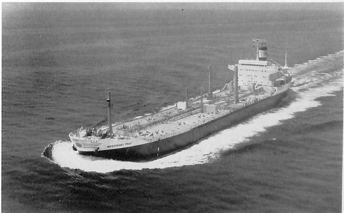
MESSINIAKI PNOI (油槽船) 船主 Marineros Glantes Novigacion S.A. (ギリシヤ) 造船所 石川島播磨重工・相生工場 総噸数 17,717.75 噸 純噸数 12,298.94 噸 遠洋 船級 LR 載貨重量 30,293 噸 全長 170.688 m 長(垂) 162.00 m 幅(型) 26.00 m 深(型) 14.35 m 吃水 11.006 m 凹甲板船 主機 IHI スルザー 7 RND 68 型ディーゼル機関 1 基 出力(最大) 115,550 PS×150 RPM (常用) 10,400 PS×114.8 RPM 燃料消費量 36.9 t/d 航続距離 23,500 海里 速力(試) 16.70 ノット (航) 15.75 ノット 貨油倉 37,914.5 m 3 燃料油倉 2,728.9 m 3 清水倉 481.0 m 3 乗員 41 名 工期 46-11, 47-2, 47-6
