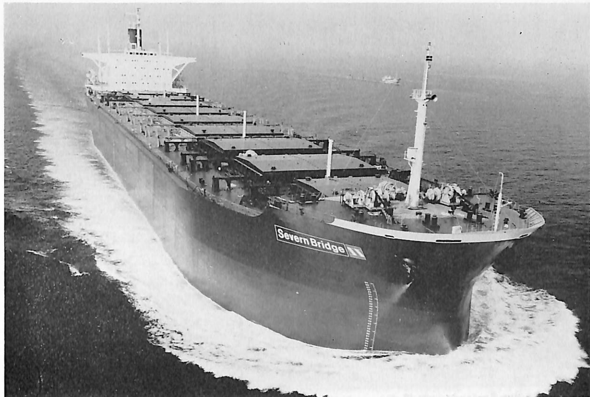
SEVERN BRIDGE (ばら積貨物船) 船主 Silver Line Ltd.(イギリス) 造船所 三菱重工業・広島造船所 総噸数 65,889.01 噸 純噸数 40,645.63 噸 遠洋 船級 LR 載貨重量 120,063 噸 全長 260.78 m 長(垂) 247.00 m 幅(型) 40.60 m 深(型) 22.50 m 吃水 16.532 m 満載排水量 140,460 噸 主機 三菱スルザー6RND 90型ディーゼル機関1基 出力 22,500 PS×116 RPM 燃料消費量 81.5 t/d 航続距離 26,500 海里 速力 15.7 ノット 貨物倉(グリーン) 131,478.3 m 3 燃料油倉 6,948.1 m 3 清水倉 519.5 m 3 乗組員 44 名 工期 47-2- 16, 47-3-13, 47-8-22 同型船 STIRLING BRIDGE
