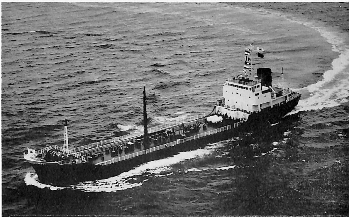
第七めつくすふあると丸 (アスファルト運搬船) 船主 株式会社 上野運輸商会 造船所 寺岡造船株式会社 総噸数 1,842.91 噸 純噸数 908.61 噸 沿海 船級 NK 載貨重量 2,751.8 噸 全長 84.25 m 長(垂) 75.00 m 幅(型) 12.00 m 深(型) 7.00 m 吃水 5.40 m 満載排水量 3,970 噸 主機 富士ディーゼル 6S40CH4C 型デ ーゼル機関 1 基 出力 2,600 PS 速力(試) 12.27 ノット (航) 12.06 ノット 発電機 150 KVA×2 62.5 KVA ×1 貨油倉 152.60 m 3 清水倉 66.10 m 3 乗員 16 名 工期 46-12-16, 47-5-10, 47-7-11
