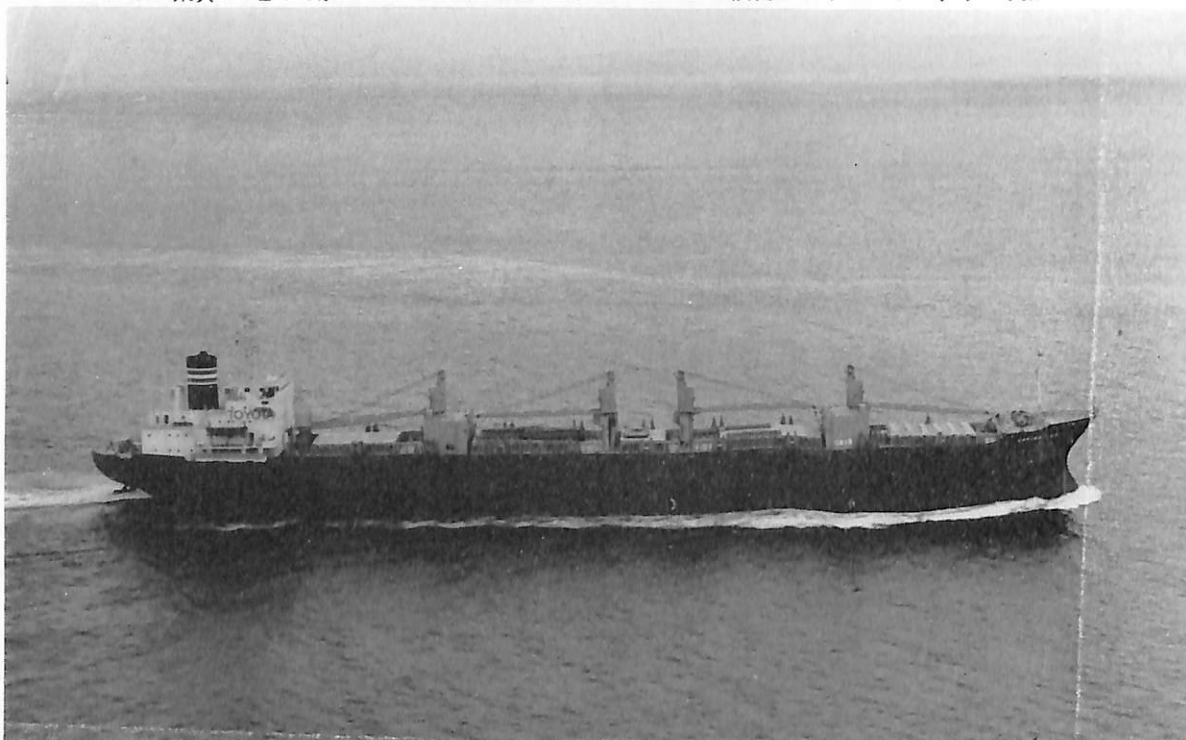
CARCASTLE (自動車兼ばら積運搬船) 船主 Brighton Shipping Company (パナマ) 造船所 株式会社 名村造船所 総噸数 17,673.63 噸 純噸数 12,990.25 噸 遠洋 船級 NK 載貨重量 30,359 噸 全長 187.03 m 長(垂) 175.00 m 幅(型) 25.00 m 深(型) 15.40 m 吃水 10.841 m 満載排水量 39,615 噸 船首楼付平甲板型 主機 三菱スルザー 7RND 68 型ディーゼル機関 1 基 出力 9,820 PS×142 RPM 燃料消費量 38.3 t/d 航続距離 17,600 海里 速力 14.6 ノット 貨物倉(ベール) 35,923 m 3 (グレーン) 37,431 m 3 自動車搭載数 (コロナ RT 43 型) 2,148 台 燃料油倉 2,231.7 m 2 清水倉 361.1 m 2 乗員 32 名 工期 46-12-21, 47-4-2, 47-8-9 設備 取外し式ポンツーン型及び吊下げ式自動車甲板
