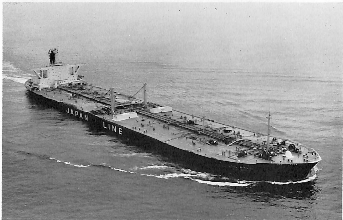
ジャパン カーネーション (油槽船) 船主 ジャパンライン株式会社 造船所 日立造船・堺工場 総噸数 120,461.48噸 純噸数 90,033.21噸 遠洋 船級 NK 載貨重量 237,660噸 全長 324.00m 長(垂) 310.00m 幅(型) 53.00m 深(型) 25.00m 吃水 19.42m 満載排水量 272,088噸 一層甲板船 主機 日立 UA-360タービン1基 出力 35,000PS×89RPM 燃料消費量 172.2t/d 航続距離 17,330海里 速力 15.7 ノット 汽罐 2 胴水管ボイラ 62kg/cm 2 72,000kg/h×2 貨油倉 282,663m 3 燃料油倉 8,058.2m 3 清水倉 335m 3 乗員 36名 工期 47-10-13, 47-2-16, 47-6-21 同型船 新燕丸, 日王丸, ジャパンルヒナス
