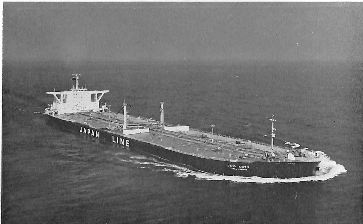
ジャパン ルヒナス (油槽船) 船主 ジャパンライン株式会社 造船所 日立造船・堺工場 総噸数 120,468.52噸 純噸数 90,063.57噸 遠洋 船級 NK 載貨重量 237,750噸 全長 324.00m 長(垂) 310.00m 幅(型) 53.00m 深(型) 25.00m 吃水 19.42m 満載排水量 272,088噸 平甲板船 主機 川崎 UA- 360タービン1基 出力 35,000PS×89RPM 燃料消費量 173.1t/d 航続距離 17,330海里 速力 15.7ノット 汽罐 2 胴水管ボイラ 62kg/cm 2 72,000kg/h×2 貨油倉 282,663.5m 3 燃料油倉 8,058.2m 3 清水倉 335m 3 乗員 36名 工期 47-1-13, 47-4-19, 47-7-26 同型船 新燕丸, 日王丸, ジャパンカーネーション
