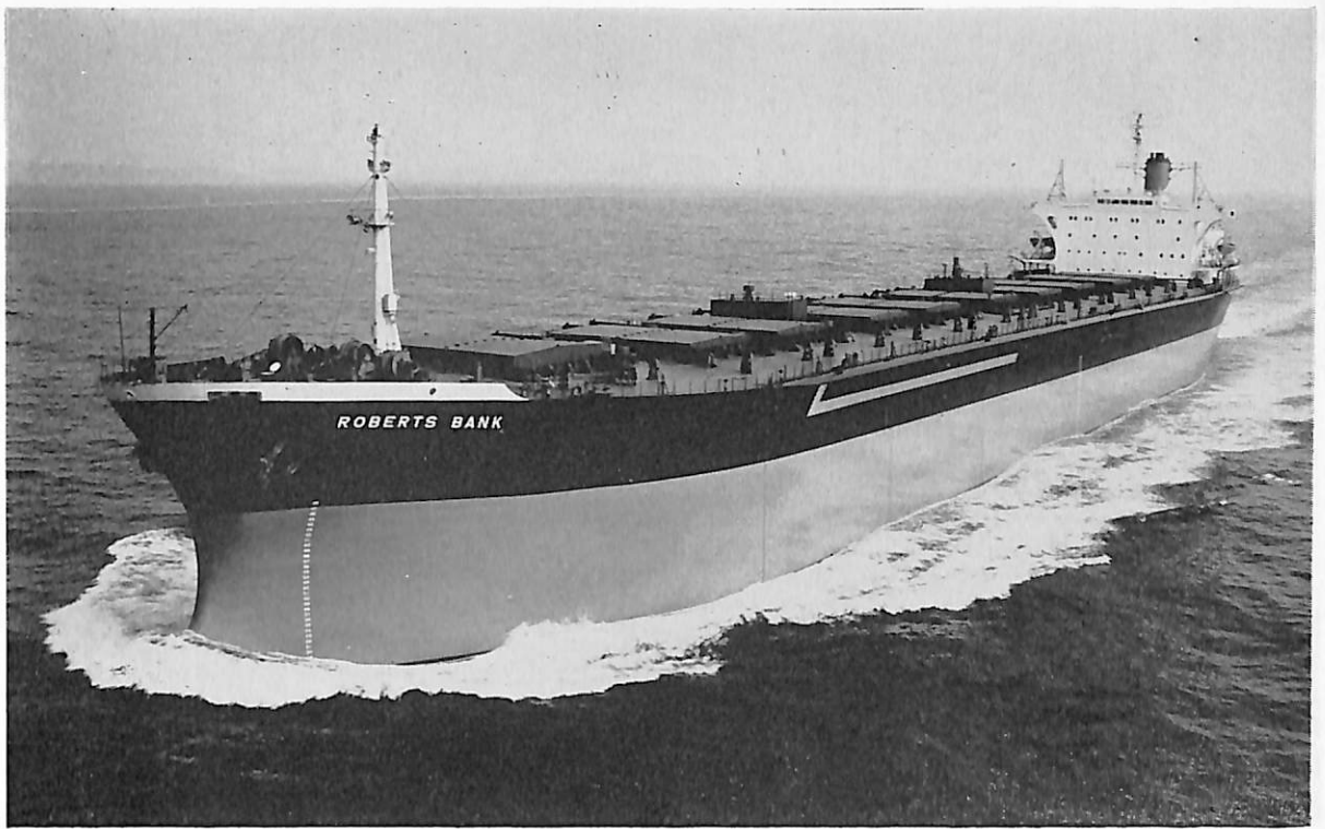
ROBERTS BANK (ばら積貨物船) 船主 United International Bulk Carriers Ltd (リベリア) 造船所 日本鋼管・鶴見造船所 総噸数 31,562.68 噸 純噸数 22,319.00 噸 遠洋 船級 AB 載貨重量 67,417 噸 全長 224.000 m 長(垂) 214.000 m 幅(型) 32.200 m 深(型) 18.700 m 吃水 13.598 m (44'-7 3 / 8 " ) 満載排水量 78,659.00 噸 平甲板型船尾機関船 主機 住友スルザー 6 RD 90 型ディーゼル機関 1 基 出力 12,750 PS×116 RPM 燃料消費量 46.7 t/d 航続距離 18,100 海里 速力 14.7 ノット 貨物倉(グリーン) 75,909.4 m 3 燃料油倉 2,920 m 3 清水倉 206.4 m 3 乗員 40 名 工期 47-1-14, 47-3-28, 47-7-27
