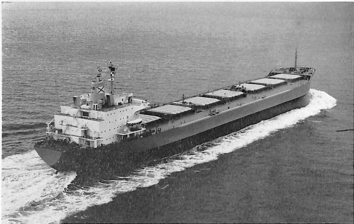
AMELIA TOPIC (ばら積貨物船) 船主 Liberty Navigaton Company (リベリア) 造船所 石川島播磨重工業・相生工場 総噸数 30,141.31 噸 純噸数 20,875.65 噸 遠洋 船級 LR 載貨重量 62,352 噸 全長 223.00m 長(垂) 213.00m 幅(型) 32.20 m 深(型) 18.30 m 吃水 12.82 m 主機 IHI スルザー 7 RND 96 型ディーゼル機関 1 基 出力(最大) 14,000 PS×122 RPM (常用) 12,600 PS×117.8 RPM 燃料消費量 46.3 t/d 航続距離 25,580 海里 速力(試) 16.87 ノット (航) 14.7 ノット 貨物倉(グリーン) 74,204.8 m 3 燃料油倉 4,019.8 m 3 清水倉 595.8 m 3 乗員 41 名 工期 46-9, 46-12, 47-3
