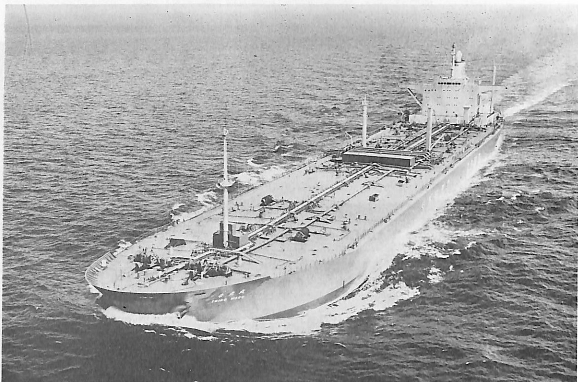
帝王丸(油槽船) 船主 三光汽船株式会社 造船所 三菱重工業・広島造船所 総噸数 61,169.68 噸 純噸数 40,711.63 噸 遠洋 船級 NK 載貨重量 112,581 噸 全長 257.00 m 長(垂) 243.00 m 幅(型) 40.00 m 深(型) 22.00 m 吃水 15.95 m 満載排水量 130,892 噸 平甲板船 主機 三菱 UEC 85 / 1E0 D型ディーゼル機関 1 基 出力 22,680 PS×111 RPM 燃料消費量 83.2 t/d 航続距離 17,000 海里 速力 15.7 ノット 汽罐(補) 53 t/h×1 貨油倉 136,930 m 3 燃料油倉 4,224 m 3 清水倉 537.0 m 3 乗員 36 名 工期 47-3-30, 47-6-23, 47-9-29 設備 イナートガス装置
