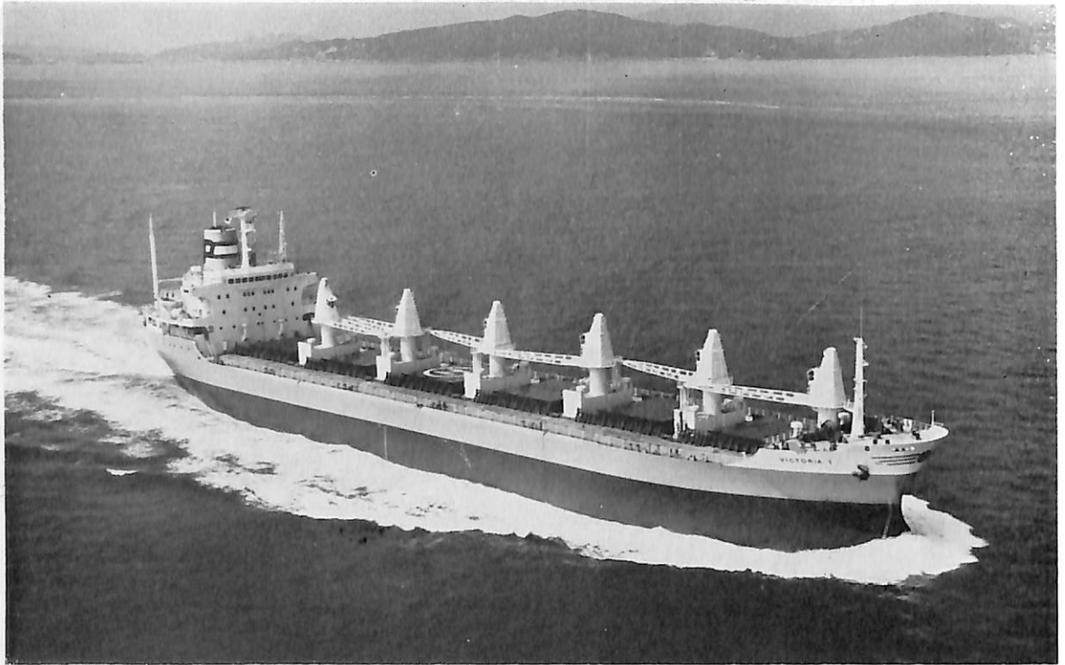
VICTORIA I (ばら積貨物船) 船主 Poramount Traders Corp. 造船所 三井造船・藤永田造船所 全長 179.00 m 長(垂) 170.00 m 幅(型) 27.00 m 深(型) 14.80 m 吃水 10.90 m 総噸数 18,953.88 噸 載貨重量 33,805 噸 貨物倉(グレーン) 44,131 m 3 速力(試) 17.202 ノット (航) 15.25 ノット 主機 三井 B&W 6 K 74 EF 型ディーゼル機関 1 基 出力(定) 11,600 PS×124 RPM (常) 10,600 PS×120 RPM 船級 LR 工期 47-3, 47-6, 47-9-14 設備 10 t デリッククレーン×6 台
