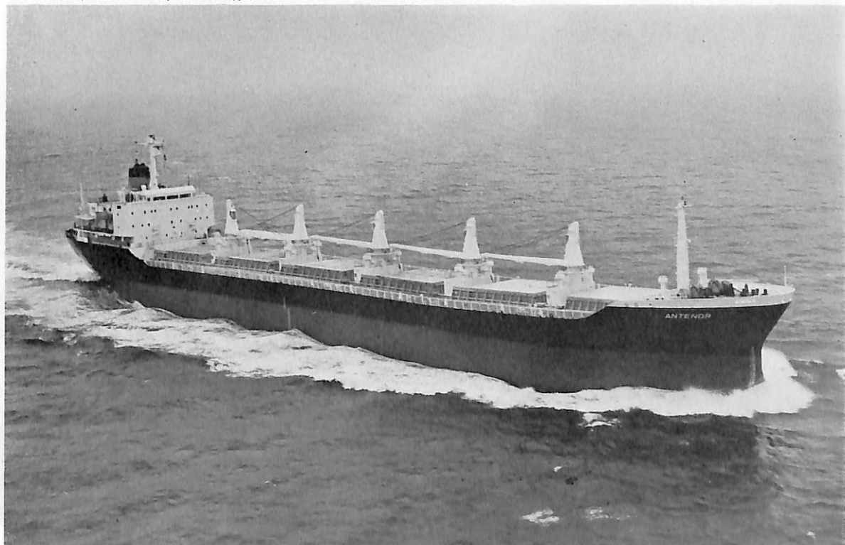
ANTENOR (ばら積貨物船) 船主 Elder Dempster Lines Ltd. (英) 造船所 三井造船・藤永田造船所 全長 176.75 m 長(垂) 168.00 m 幅(型) 22.86 m 深(型) 14.10 m 吃水 10.666 m 総噸数 16,405.77 噸 載貨重量 26,725 噸 貨物倉(グリーン) 31,814 m 3 速力(試) 17.563 ノット (航) 15.25 ノット 主機 三井 B&W 6 K 74 EF 型ディーゼル機関 1 基 出力(連続最大) 11,600 PS×124 RPM (満載航海) 10,600 PS×120 RPM 乗員 39 名 船級 AB 工期 47-4, 47-7, 47-9-30
