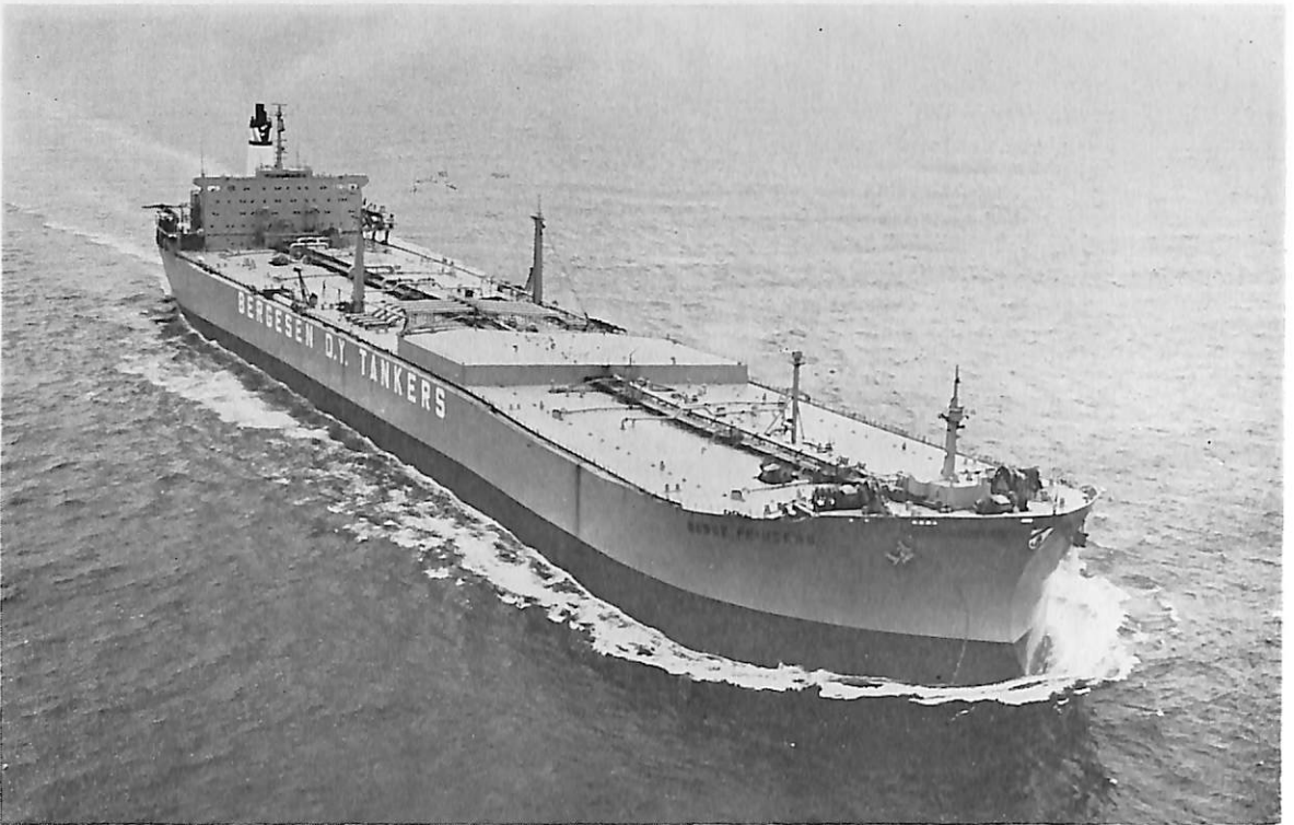
BERGE PRINCESS (油槽船) 船主 Sig Bergesen d. y. & Co. (ノルウェー) 造船所 三井造船・千葉 造船所 全長 342.90 m 長(垂) 329.184 m 幅(型) 51.816 m 深(型) 27.737 m 吃水 21.773 m 総噸数 139,775.62 噸 載貨重量 280,015 噸 貨油倉 342,043.7 m 3 速力(最大) 15.55 ノット 主機 三井 B&W 9 K 8 EF 型ディーゼル機関 1 基 出力(最大) 35,300 PS×106 RPM 乗員 44 名 船級 LR 工期 47-1, 47- -6, 47-9-29 設備 LR の "UMS" 取得船
