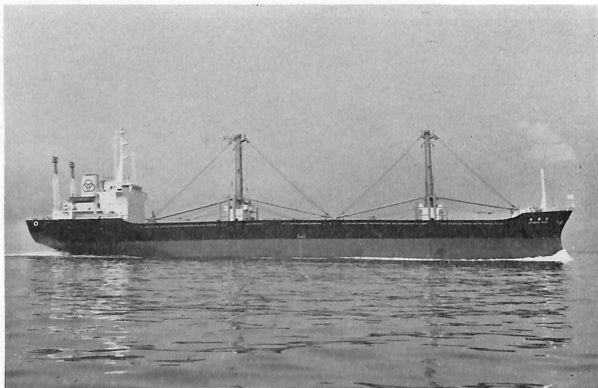
聖潮丸 (木材兼ばら積貨物船) 船主 長鋪汽船株式会社 造船所 新山本造船所・高知造船所 総噸数 10,238.64 噸 純噸数 6,499.96 噸 遠洋 船級 NK 載貨重量 17,249 噸 全長 146.40 m 長(垂) 136.00 m 幅(型) 22.60 m 深(型) 12.10 m 吃水 8.947 m 凹甲板船 主機 赤坂 8 UEC 52/105 C 型ディーゼル機関 1 基 出力 6,120 PS×166 RPM 燃料消費量 24 t/d 航続距離 15,000 海里 速力 13.80 ノット 貨物倉(ベール) 20,459 m 3 (グレーン) 21,483 m 3 燃料油倉 2,200 m 3 清水倉 896 m 3 乗組員 30 名 工期 47-4-22, 47- 7-22, 47-9-20
