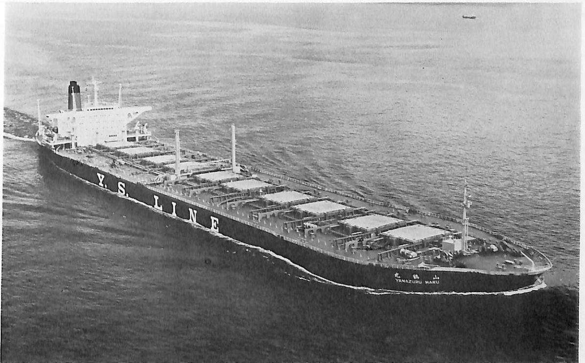
山 鶴 丸 (鉸石兼油槽船) 船主 山下新日本汽船株式会社, 山和商船株式会社 造船所 日立造船 因島工場 総噸数 89,426.34 噸 純噸数 62,568.44 噸 遠洋 船級 NK 載貨重量 165,062 噸 全長 300.00 m 長(垂) 289.00 m 幅(型) 48.00 m 深(型) 23.00 m 吃水 17.12 m 満載排水量 196,527 噸 平甲板船 主機 日立 B&W 12 K 84 EF 型ディーゼル機関 1 基 出力 26,270 PS×108 RPM 航続距離 26,500 海里 速力 15.5 ノット 貨油倉 202,307.78 m 3 鉸石倉 92,814.14 m 3 燃料油倉 7,839.39 m 3 清水倉 1,000.72 m 3 乗員 39 名 工期 47-1-13, 47-5-16, 47-8-31 同型船 若鶴丸
