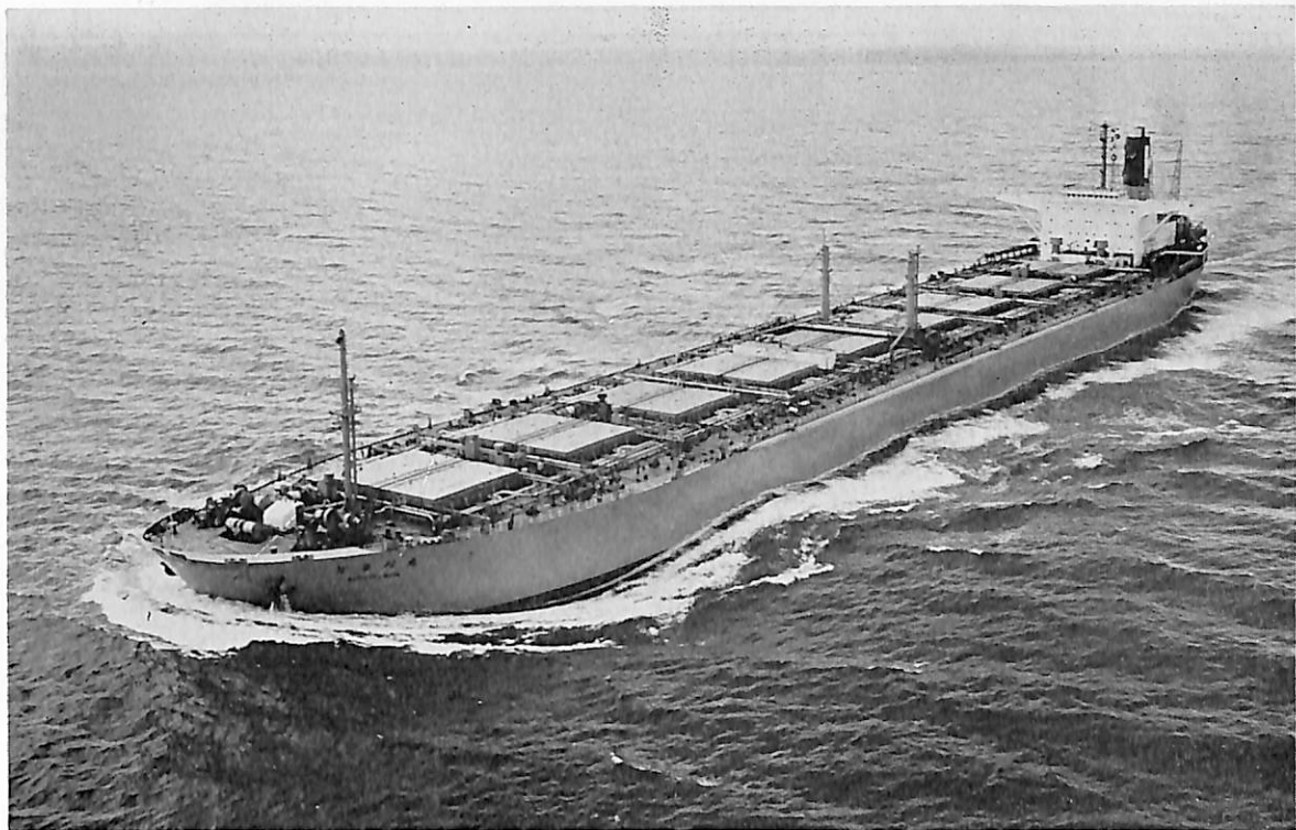
万喜川丸 (ばら積兼油槽船) 船主 川崎汽船株式会社, 大洋海運株式会社 造船所 石川島播磨重工・呉造船所 総噸数 90,485.13 噸 純噸数 63,251.57 噸 遠洋 船級 NK 載貨重量 156,109 噸 全長 305.00 m 長(垂) 290.00 m 幅(型) 43.30 m 深(型) 24.70 m 吃水 17.435 m 平甲板型 主機 IHI スルザー 8RND 105 型ディーゼル機関 1 基 出力 27,200 PS×102.4 RPM 燃料消費量 97.57 t/d 航続距離 40,550 海里 速力 16.2 ノット 汽罐 2 胴水管式 1 貨物倉(グリーン) 187,453.4 m 3 貨油倉 187,453.4 m 3 燃料油倉 10,676.2 m 3 清水倉 728.2 m 3 乗員 36 名 工期 46-12-17, 47-5-4, 47-9-1
