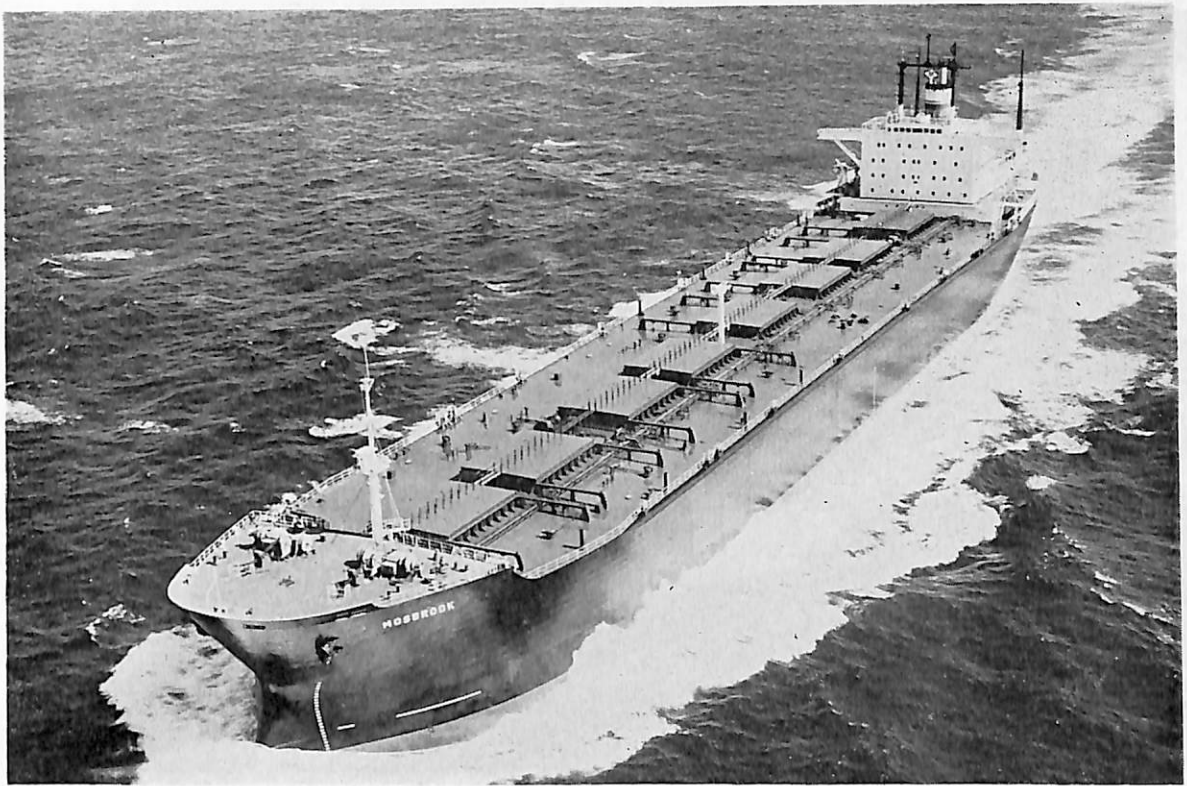
MOSBROOK (鉱石運搬船) 船主 A/S Mosvolds Rederi (ノルウェー) 造船所 三菱重工業・横浜造船所 総噸数 45,857.45 噸 純噸数 25,742.45 噸 遠洋 船級 NV 載貨重量 83,776 噸 全長 239.00 m 長(垂) 226.00 m 幅(型) 36.00 m 深(型) 19.65 m 吃水 14.335 m 船首楼付平甲板船 主機 三菱スルザー 6 RND 90 型デ ィーゼル機関 1 基 出力 18,270 PS×118 RPM 燃料消費量 66 t/d 航続距離 38,900 海里 速力 15.55 ノット 貨物倉(グリーン) 46,394 m 3 燃料油倉 8,219 m 3 清水倉 512 m 3 乗員 43 名 (外パイロット 1 名) 工期 47- 2-22, 47-6-28, 47-9-29 同型船 MOSLANE 設備 外部電源方式船体防食装置
