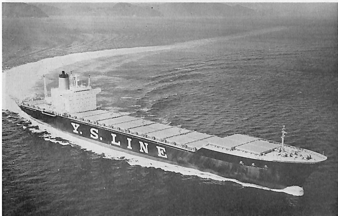
東 米 丸 (コンテナ船) 船主 山手新日本汽船株式会社 造船所 日立造船・因島工場 総噸数 35,491.76 噸 純噸数 18,846.45 噸 遠洋 船級 NK 載貨重量 28,760 噸 全長 245.93 m 長(垂) 230.00 m 幅(型) 32.00 m 深(型) 19.00 m 吃水 10.50 m 満載排水量 45,129 噸 長船首楼付一層甲板船 主機 川崎 KHI-450 クロスコンパウンドタービン 1 基 出力 42,500 PS×103 RPM 燃料消費量 216.8 t/d 航続距離 15,100 海里 速力 24.35 ノット 貨物倉(コンテナ) 20' 1,610 箇(甲板上 3 段) 燃料油倉 6,348.21 m 3 清水倉 722.68 m 3 乗員 34 名 工期 46-11-15, 47-3-16, 47-8-19
