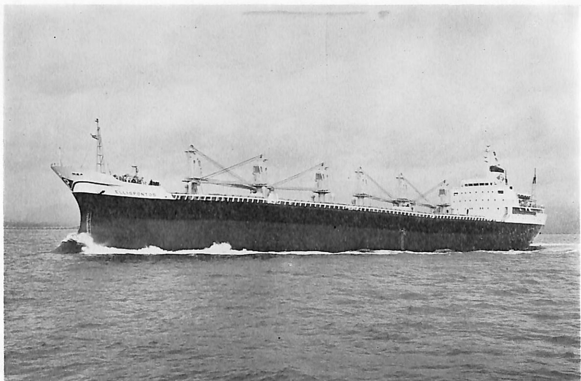
ELLISPONTOS (ばら積貨物船) 船主 Ayr Shipping Corporation (リベリア) 造船所 函館ドック・函館造船所 総噸数 16,206.71 噸 純噸数 10,329.98 噸 遠洋 船級 LR 載貨重量 28,647 噸 全長 180.80 m 長(垂) 170.00 m 幅(型) 23.10 m 深(型) 14.50 m 吃水 35' - 1/2" 満載排水量 35,241 噸 船首尾楼付一層甲板船 主機 IHI-スルザー 7 RND 76 型ディーゼル機関 1 基 出力 10,080 PS×118 RPM 燃料消費量 38.45 t/d 航続距離 18,300 海里 速力 15.0 ノット 貨物倉(ペール) 1,150.769 ft 3 (グリーン) 1,303.724 ft 3 燃料油倉 C 76,482 ft 3 A 6,635 ft 3 清水倉 8,774 ft 3 乗員 40 名 工期 47-4-20, 47-7-18, 47-9-29
