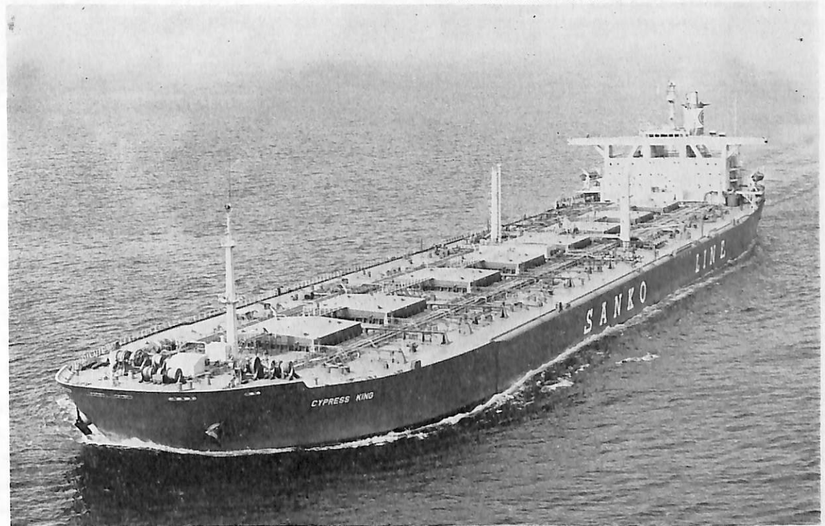
CYPRESS KING (鉱石兼油槽船) 船主 Cypress Maritime Corporation (リベリア) 造船所 三菱重工 業・横浜造船所 総噸数 94,989.99 噸 純噸数 67,469.86 噸 遠洋 船級 NK 載貨重量 164,545 噸 全長 294.95 m 長(垂) 280.00 m 幅(型) 47.40 m 深(型) 24.80 m 吃水 17.50 m 平甲板型 主機 三菱船用パッケ ージド 2 シリンダ 2 段減速装置付タービン 1 基 出力 28,000 PS×88 RPM 燃料消費量 139 t/d 航続距離 28,400 海里 速力 16.0 ノット 貨物倉(グリーン) 94,999 m 3 貨油倉 207,477 m 3 燃料油倉 11,777 m 3 清水倉 526 m 3 工期 46-12-24, 47-5-4, 47-9-14
