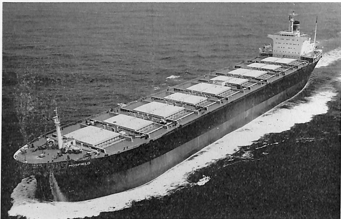
MOSFIELD (ばら積貨物船) 船主 A/S Mosbuike.s (ノールウェー) 造船所 住友重機械工業・浦賀造船所 総噸数 64,726.86 噸 純噸数 46,083.19 噸 遠洋 船級 NV 載貨重量 117,804 LT 全長 256.00 m 長(垂) 244.00 m 幅(型) 40.20 m 深(型) 23.90 m 吃水 16.915 m 満載排水量 137,962 LT 平甲板型 主機 住友ス ザー 8 RND 90 型ディーゼル機関 1 基 出力 19,700 PS×118 RPM 燃料消費量 75.5 t/d 航続距離 24,600 海里 速力 15.26 ノット 貨物倉(グレーン) 139,075 m 3 燃料油倉 6,111 m 3 清水倉 480 m 3 乗員 44 名 工期 47- 2-16. 47-5-12. 47-8-31 設備 最大級ばら積貨物船, 鉾石の交互貨物倉積
