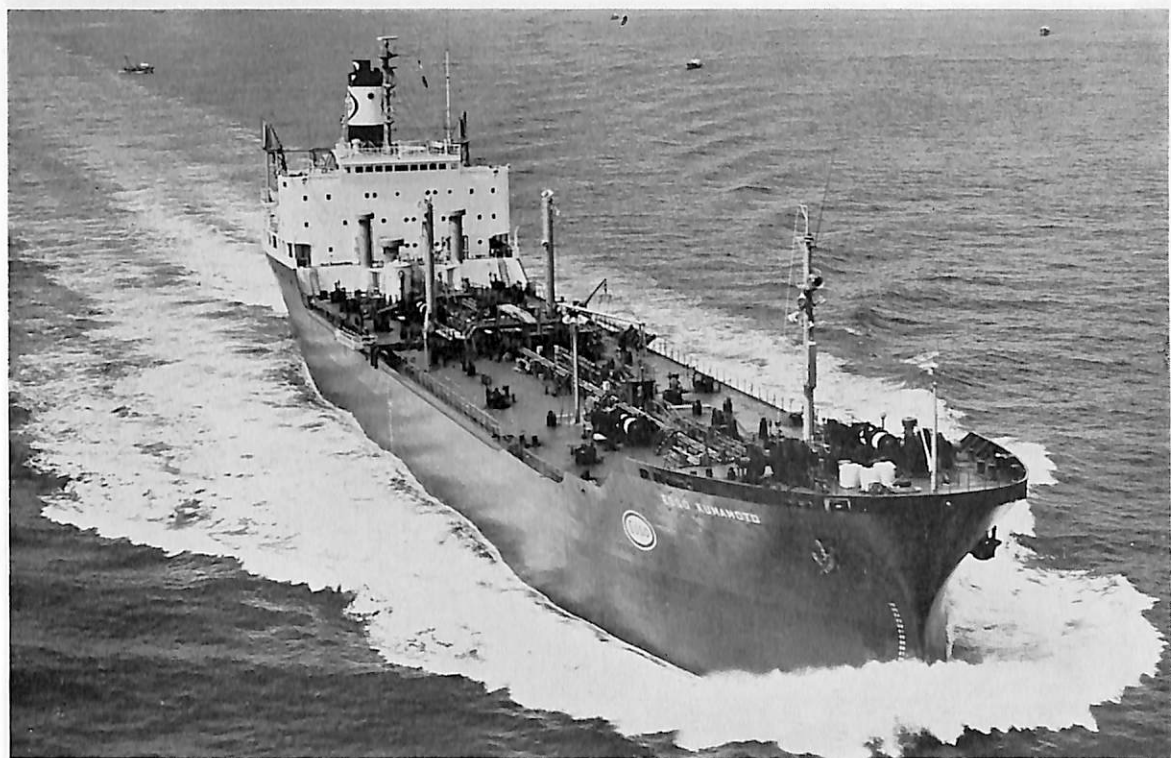
ESSO KUMAMOTO (油槽船) 船主 Esso Tankers Inc. (米) 造船所 日立造船・向島工場 総噸数 12,820.95 噸 純噸数 7,594 噸 遠洋 船級 AB 載貨重量 22,367 噸 全長 161.20 m 長(垂) 152.00 m 幅(型) 23.50 m 深(型) 12.75 m 吃水 32'-1 5 / 8 " 満載排水量 28,463 噸 船尾楼付一層甲板船 主機 日立 B&W 7 K 62 EF 型ディーゼル機関 1 基 出力 8,600 PS×140 RPM 燃料消費量 35.3 t/d 航続距離 10,000 海里 速力 15.0 ノット 貨油倉 930,517 m 3 燃料油倉 66,843 ft 3 清水倉 66.57 ft 3 乗員 36 名 工期 47-1- 28, 47-5-26, 47-9-7
