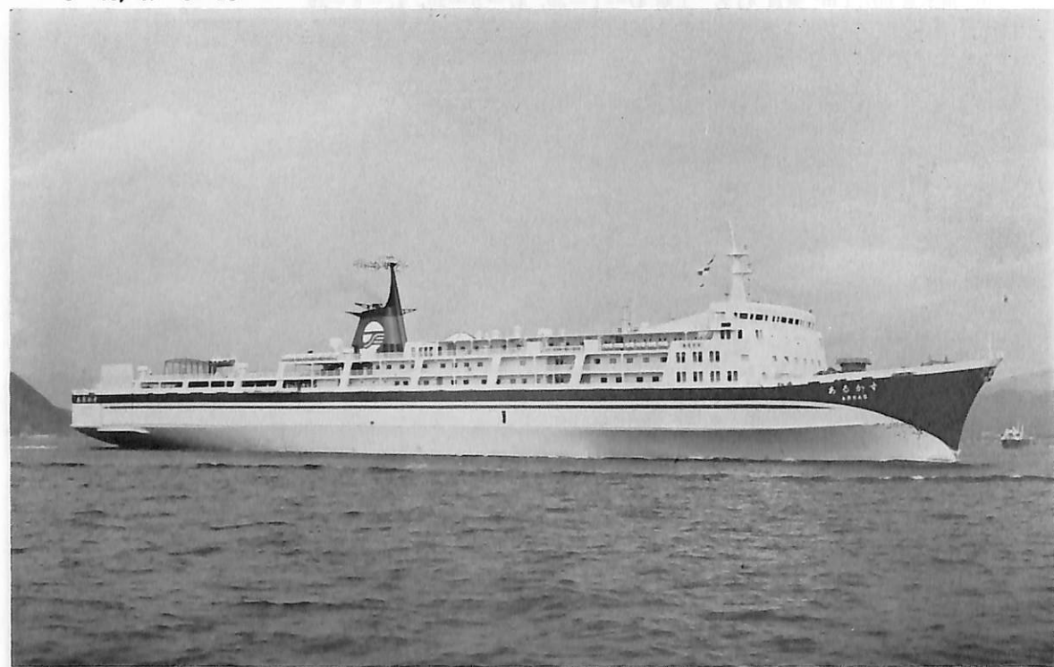
あるかす(自動車航送旅客船) 船主 太平洋沿海フェリー株式会社 造船所 瀬戸田造船株式会社 総噸数 9,695.70 噸 純噸数 5,042.84 噸 近海 船級 JG 載貨重量 3,363 噸 全長 167.22 m 長(垂) 155.00 m 幅(型) 24.00 m 深(型) 9.70 m 吃水 6.45 m 満載排水量 10,640 噸 全通船楼二層甲板船 主機 日立 B&W 16 U 45 HU 型ディーゼル機関 2 基 出力 8,000 PS×171 RPM 燃料消費量 63.25 t/d 航続距離 4,871 海里 速力 21.10 ノット 諸車搭載台数 車両甲板上 8 トン積トラック 95 台 船楼甲板上 乗用車 75 台 燃料油倉 633.94 m 3 清水倉 1,126.98 m 3 旅客 925 名 乗員 69 名 工期 46-9-28, 47-4-13, 47-9-11
