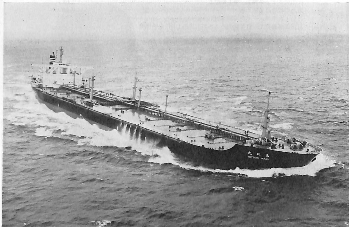
鳥取丸(油槽船) 船主 日本郵船株式会社, 太平洋海運株式会社 造船所 三菱重工業・長崎造船所 総噸数 116,142.68 噸 純噸数 90,332.79 噸 遠洋 船級 NK 載貨重量 237,383 噸 全長 321.82 m 長(垂) 304.00 m 幅(型) 52.40 m 深(型) 25.70 m 吃水 19.85 m 満載排水量 271,391 噸 主機 三菱船用パッケージド減速装置付タービン 1 基 出力 34,000 PS×90 RPM 燃料消費量 約 166.5 t/d 航続距離 約 16,000 海里 速力 15.8 ノット 貨油倉 289,267.3 m 3 燃料油倉 8,192.3 m 3 清水倉 760.1 m 3 工期 46-12-1, 47-4-11, 47-9-5 同型船 隆洋丸 設備 タービン船としてわが国初のトータルコンピュータシステム採用
