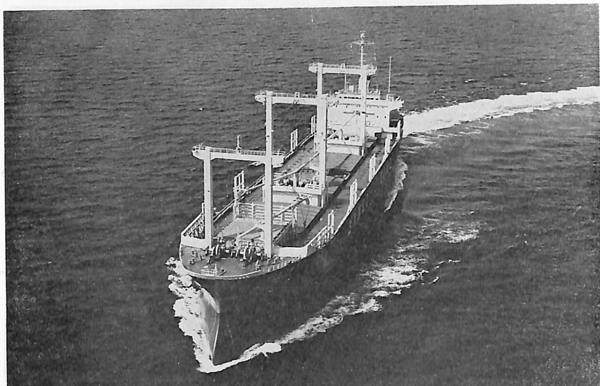
かすね丸 (木材兼ばら積貨物船) 船主 三光汽船株式会社 造船所 株式会社 金指造船所 総噸数 19,968.88 噸 純噸数 12,964.91 噸 遠洋 船級 NK 載貨重量 32,628 噸 全長 182.00 m 長(垂) 170.00 m 幅(型) 27.00 m 深(型) 15.20 m 吃水 10.823 m 満載排水量 40,728 噸 凹甲板船 主機 三井 B&W 6 K 74 EF 型ディーゼル機関 1 基 出力 10,600 PS×120 RPM 燃料消費量 156 g/ps.h 航続距離 15,000 海里 速力 14.8 ノット 貨物倉(ベール) 39,819 m 3 (グレーン) 41,476 m 3 燃料油倉 A 211 m 3 C 2,069 m 3 清水倉 535 m 3 乗員 38 名 工期 47 2-6, 47-6-23, 47-9-28 同型船 ない丸
