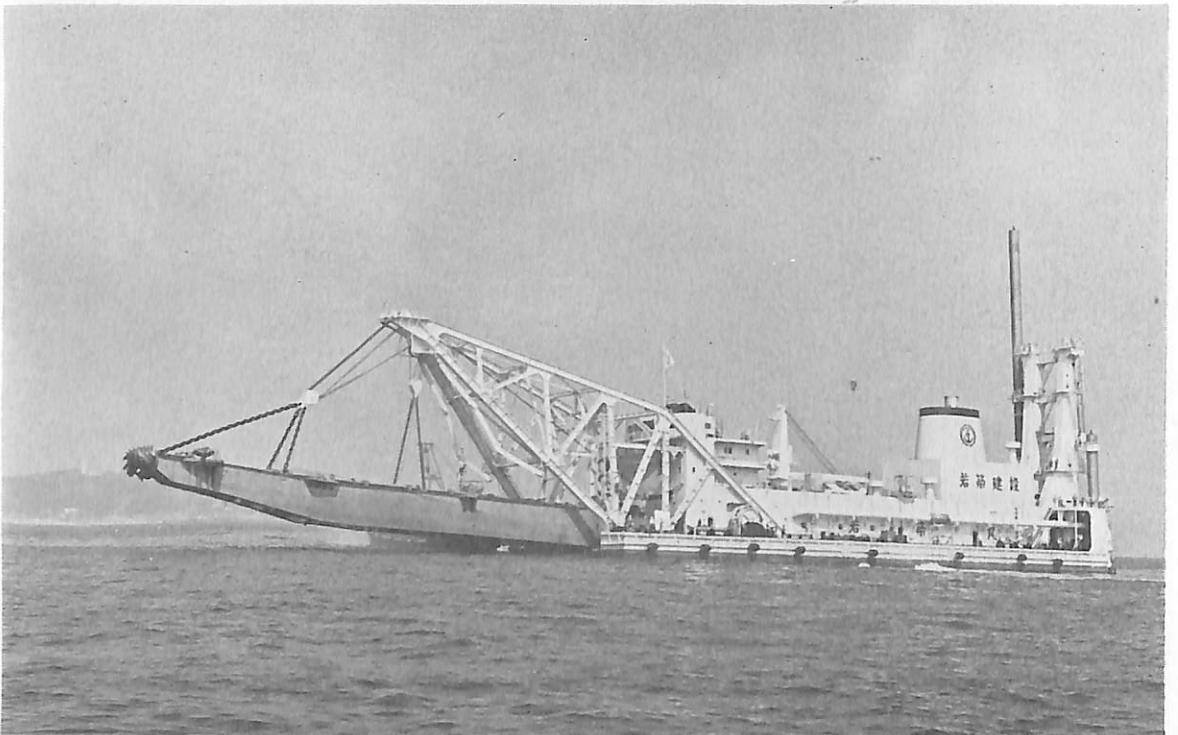
若 築 丸 (浚 浚 船) 船主 若築建設株式会社 造船所 住友重機械工業・浦賀造船所 長(垂) 75.60 m 幅(型) 20.00 m 深(型) 5.30 m 満載吃水 約 3.70 m 浚浚ポンプ駆動用原動機 9,200馬 力衝動式蒸気タービン 浚浚ポンプ 9,000m 3 /h \times 120 m(清水にて) 浚浚深度 約 30m(ラダーアングル40°に て) 排送距離 約 5,000m 管径 排出管 760mm, 吸入管 840mm 工期 47-4-5, 47-6-12, 47-9-30 特長 1. 浚浚ポンプ駆動用原動機として, 9,200馬力衝動式蒸気タービンを備える。2. 機関部, 浚浚機械部を できるかぎり自動化, 省力化している。3. 公害を発生しないよう対策を講じている。
