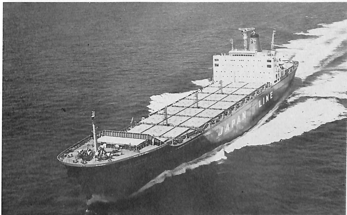
ジャパン アムブローズ (コンテナ船) 船主 ジャパンライン株式会社 造船所 石川島播磨重工・相生工場 全長 228.00 m 長(垂) 215.00 m 幅(型) 32.20 m 深(型) 19.00 m 吃水 11.028 m 総噸数 33,287 噸 載貨重 量 28,806 噸 コンテナ積載数 20' にて 1,569 個 速力(航) 25.1 ノット 主機 IHI-衝動式 2 シリンダークロス コンパウンド 2 段減速装置付蒸気タービン 1 基 出力 50,000 PS 船級 NK (M0 船) 工期 49-11-11, 47-3-24, 47-6-2
