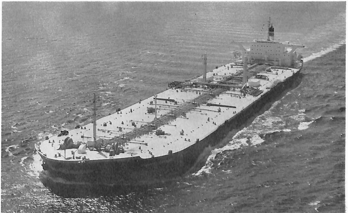
IOANNIS CHANDRIS (油槽船) 船主 Achilles Navigation Corporation (リベリア) 造船所 日立造船・ 堺工場 総噸数 124,257.46 噸 純噸数 105,729 噸 遠洋 船級 AB 載貨重量 266,428 噸 全長 331.00 m 長 (垂) 316.00 m 幅(型) 51.20 m 深(型) 28.30 m 吃水 21.981 m 満載排水量 301,421 噸 主機 日立 UA-360 型蒸気タービン 1 基 出力 35,000 PS×89 RPM 燃料消費量 169.5 t/d 航続距離 約 19,300 海里 速力 15.6 ノット 貨油倉 11,762.469 ft 3 燃料油倉 342,003 ft 3 清水倉 32,228 ft 3 乗員 49 名 工期 47-2-14, 47-6-28, 47-9-29
