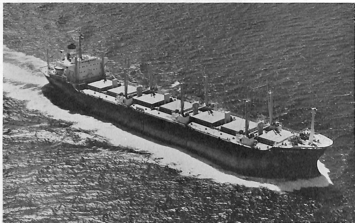
INVERSHIN (ばら積貨物船) 船主 Christian Salvesen Limited (英国) 造船所 株式会社 名村造船所 総噸数 18,070.64 噸 純噸数 11,356.40 噸 遠洋 船級 LR 載貨重量 30,164 噸 全長 172.02 m 長(垂) 162.00 m 幅(型) 25.00 m 深(型) 15.20 m 吃水 11.000 m 満載排水量 37,287 噸 凹甲板型 主機 三菱神戸 6RND 76 型ディーゼル機関 1 基 出力 10,200 PS×166 RPM 燃料消費量 C 37.5 t/d A 2.2 t/d 航続距離 16,500 海里 速力 14.9 ノット 貨物倉(グリーン) 38,955.2 m 3 燃料油倉 2,638.5 m 3 清水倉 335.8 m 3 乗員 50 名 工期 47-1-20, 47-4-28, 47-8-29
