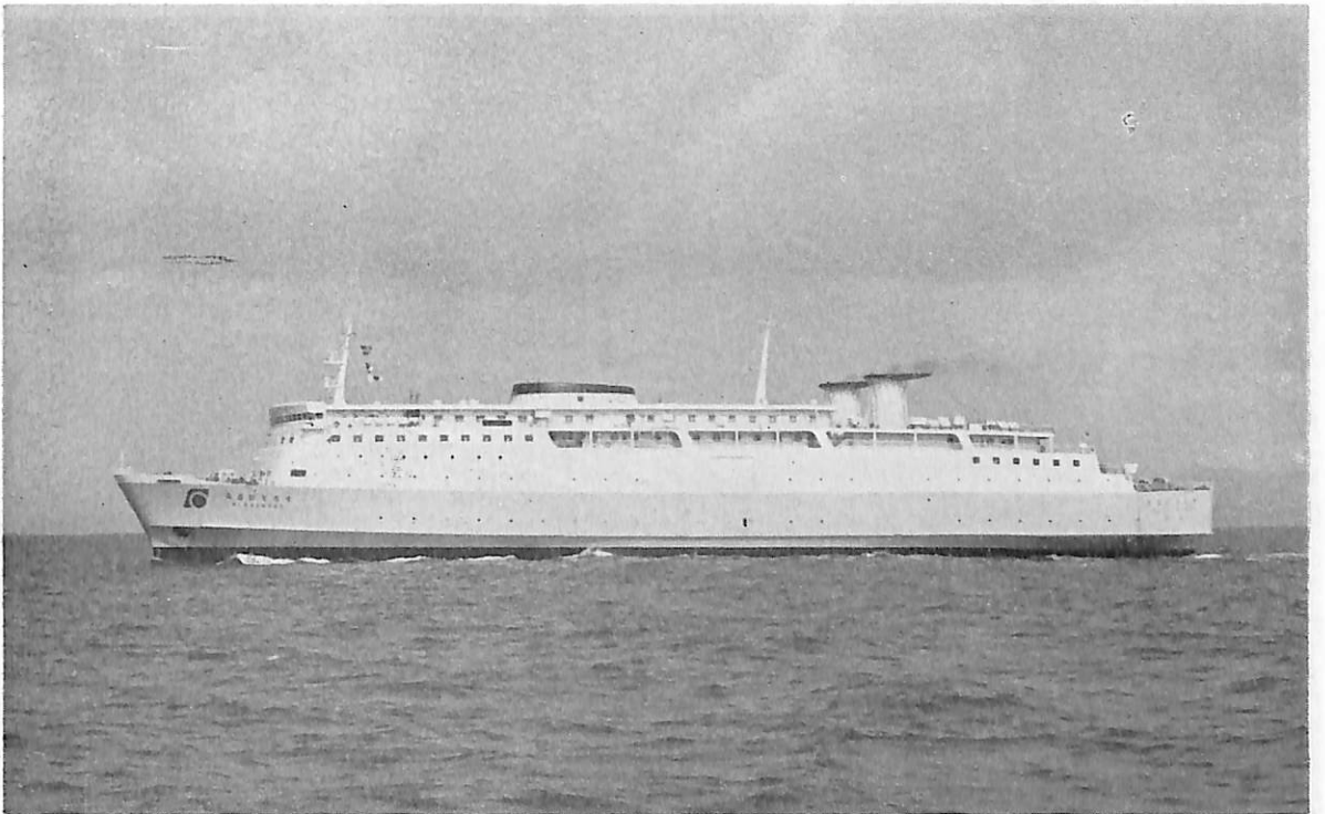
あるばとろす(自動車航送客船) 船主 オーシャンフェリー株式会社 造船所 波浜造船株式会社 総噸数 7,653.94 噸 純噸数 3,768.35 噸 近海 載貨重量 2,713.79 噸 全長 137.85 m 長(垂) 127.00 m 幅(型) 23.40 m 深(型) 7.30 m 吃水 5.619 m 満載排水量 8,430.00 噸 全通船楼型 主機 IHI 18PC-2V 型ディーゼ ル機関 2 基 出力 2×8,109 PS×492.4/180 RPM 燃料消費量 67.5 t/d 航続距離 3,140 海里 速力 約 21.5 ノ ット 最大搭載人員 974 名 車輛搭載数 8 t 積トラック 105 台 小型乗用車 86 台 燃料油倉 A 136.46 m 3 C 490.10 m 3 清水倉 313.50 m 3 乗員 79 名 工期 47-1-27, 47-5-12, 47-10-7 同型船 かしおべあ
