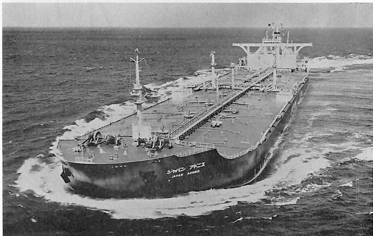
ジャパン アドニス (油槽船) 船主 ジャパンライン株式会社 造船所 三菱重工業・長崎造船所 総噸数 117,573.67 噸 純噸数 88,258.18 噸 遠洋 船級 NK 載貨重量 237,093 噸 全長 321.82 m 長(垂) 304.00 m 幅(型) 52.40 m 深(型) 25.70 m 吃水 19.850 m 船首楼付平甲板船 主機 三菱船用パッケージド 減速装置付タービン 1 基 出力 34,000 PS×90 RPM 燃料消費量 約 166.5 t/d 航続距離 約 16,500 海里 速力 15.8 ノット 貨油倉 289,267.3 m 3 燃料油倉 8,265.5 m 3 清水倉 760.1 m 3 乗員 36 名 工期 47-3-27, 47- 6-27, 47-9-29 同型船 隆洋丸
