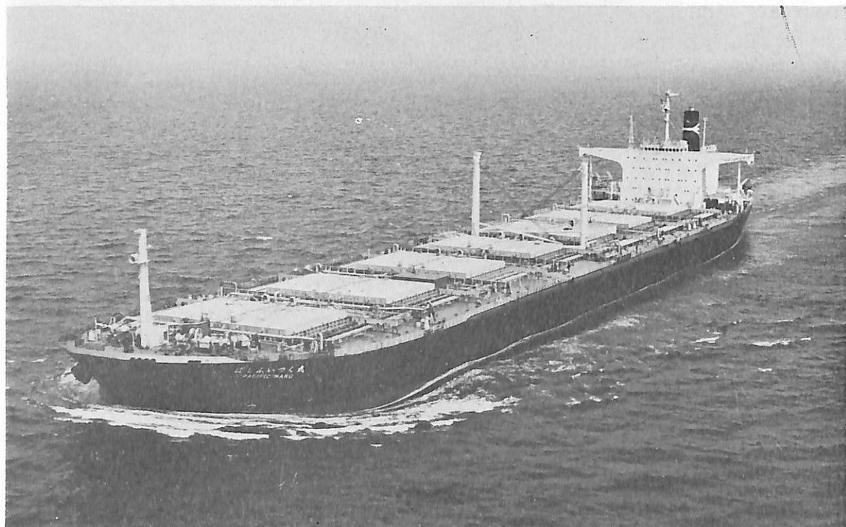
ばしふいっく丸 (鉍石, 石炭, 油兼用船) 船主 第一中央汽船株式会社 造船所 住友重機械工業・追浜 造船所 総噸数 96,045.04 噸 純噸数 77,749.22 噸 遠洋 船級 NK 載貨重量 168,400 噸 全長 297.50 m 長(垂) 285.00 m 幅(型) 47.40 m 深(型) 24.80 m 吃水 17.609 m 満載排水量 200,510 噸 平甲板船 主機 住友 STAL LAVAL AP-タービン 1 基 出力 25,800 PS×83 RPM 燃料消費量 128.4 t/d 航続距離 28,000 海里 速力 15.57 ノット 貨物倉(グレーン) 157,255 m 3 貨油倉 211,374 m 3 燃料油倉 9,684 m 3 清水倉 380 m 3 乗員 38 名 工期 47-1-13, 47-6-30, 47-9-29
