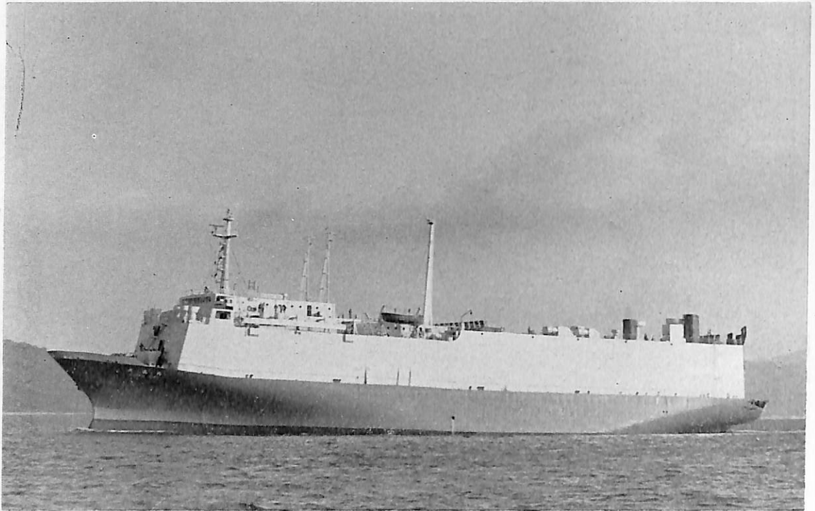
大 真 丸 (自動車運搬船) 船主 枳本海運産業株式会社 造船所 波止浜造船株式会社 総噸数 3,299.25 噸 純噸数 1,628.81 噸 遠洋 船級 NK 載貨重量 3,723.57 噸 全長 130.58 m 長(垂) 118.00 m 幅(型) 18.30 m 深(型) 6.90 m 吃水 6.32 m 満載排水量 8,090.00 噸 全通船楼型 主機 IHI-16PC-2 V型ディーゼル機関1基 出力1×6,800 PS×474/172.3 RPM 燃料消費量 30.6 t/d 航続距離 16,100 海里 速力 17.10 ノット 車輛搭載数 中型乗用車 1,250 台 燃料油倉 A 109.09 m 3 C 1,267.60 m 3 清水倉 331.92 m 3 乗員 29 名 工期 47-5-10, 47-7-13, 47-9-29
