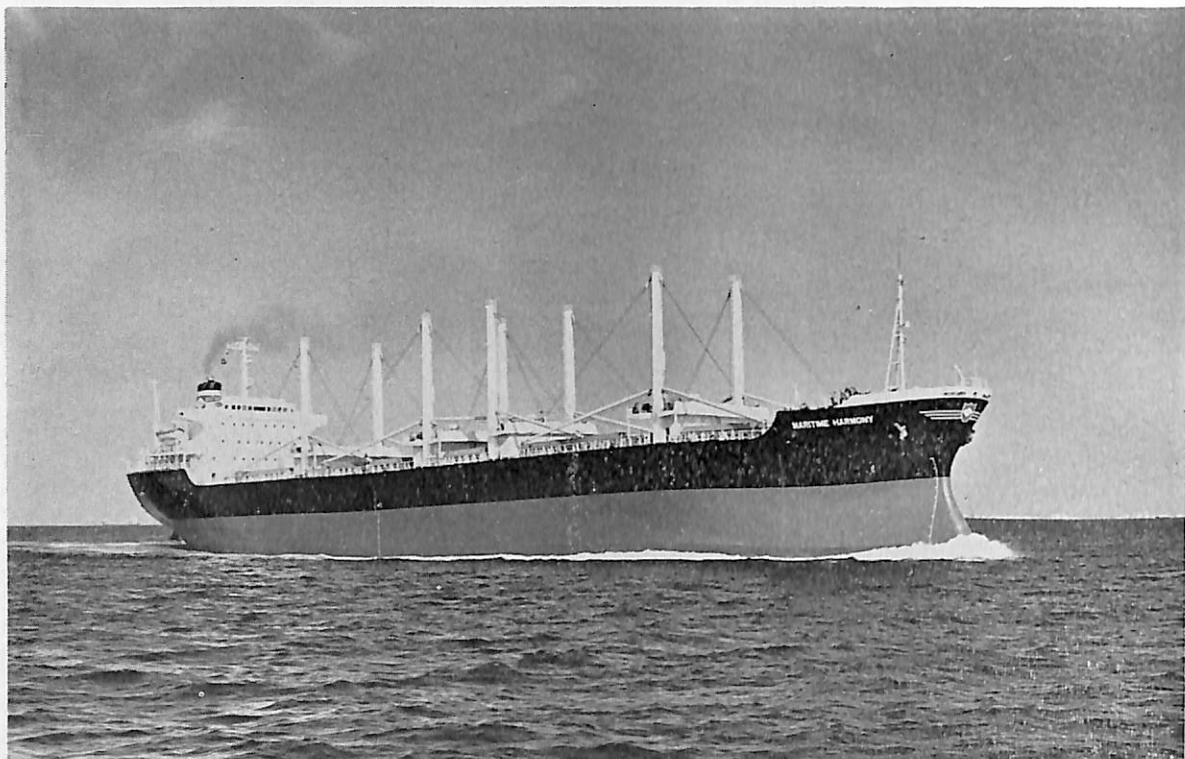
MARITIME HARMONY (ばら積貨物船) 船主 Vincent Shipping Corporation (リベリア) 造船所 株式会社 大阪造船所 総噸数 19,712.52 噸 純噸数 13,867 噸 遠洋 船級 AB 載貨重量 34,194 噸 全長 185.500 m 長(垂) 175.000 m 幅(型) 26.000 m 深(型) 15.500 m 吃水 11.151 m 満載排水量 41,748 噸 凹甲板型 主機 三菱スルザー 7RND 68 型ディーゼル機関 1 基 出力 10,395 PS×144.8 RPM 燃料消費量 41.9 t/d 航続距離 約 16,460 海里 速力 14.6 ノット 貨物倉(ベール) 41,242 m 3 (グリーン) 44,735 m 3 燃料油倉 2,164.9 m 3 清水倉 432.4 m 3 乗員 46 名 工期 47-4-26, 47-8-2, 47-10-20
