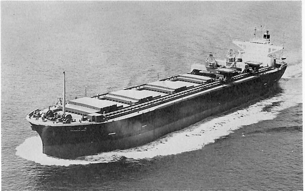
八 戸 丸 (チップ運搬船) 船主 日本郵船株式会社, 正福汽船株式会社 造船所 日立造船・舞鶴工場 総噸数 40,571.34 噸 純噸数 32,001.85 噸 遠洋 船級 NK 載貨重量 54,187 噸 全長 229.928 m 長(垂) 218.00 m 幅(型) 33.60 m 深(型) 19.50 m 吃水 11.00 m 満載排水量 67,382 噸 平甲板船 主機 日立 B&W 6 K 74 EF 型ディーゼル機関 1 基 出力 9,860 PS×118 RPM 燃料消費量 39.53 t/d 航続距離 20,040 海里 汽罐(補) 日立フレミングボイラ No. 3×1 発電機 自己通風防滴型 770 KVA, AC 450 V, 60 Hz×3 貨物倉 96,905 m 3 燃料由倉 2,350.52 m 3 清水倉 855.46 m 3 乗員 34 名 工期 47-1-11, 47-4-17, 47-9-30
