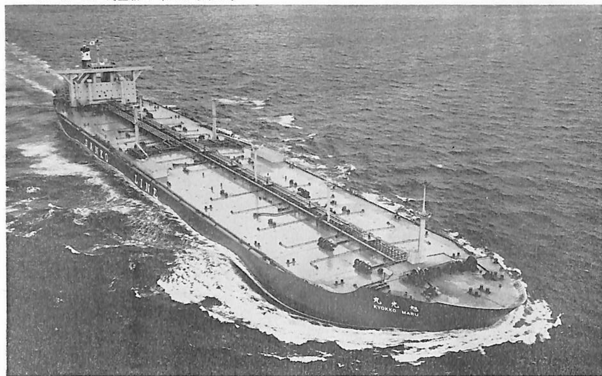
旭 光 丸 (油 槽 船) 船主 三光汽船株式会社 造船所 三菱重工業・長崎造船所 総噸数 117,568.98 噸 純噸数 88,390.69 噸 遠洋 船級 NK 載貨重量 237,204 噸 全長 321.82 m 長(垂) 304.00 m 幅(型) 52.40 m 深(型) 25.70 m 吃水 19.887 m 船首楼付平甲板船 主機 三菱 2 段減速装置付タービン 1 基 出力 34,000 PS×90 RPM 燃料消費量 166.5 t/d 航続距離 17,000 海里 速力 15.8 ノット 貨油倉 289,267.3 m 3 燃料油倉 8,271.1 m 3 清水倉 760.1 m 3 乗員 39 名 工期 47-1-21, 47-8-31, 47-11-22 同型船 新光丸 設備 イナートガスシステム装置
