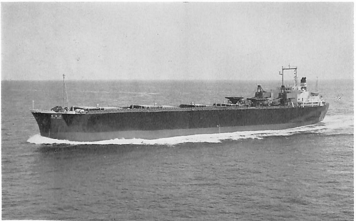
豊 陽 丸 (チップ運搬船) 船主 八馬汽船株式会社, 日本郵船株式会社 造船所 日本鋼管・清水 造船所 総噸数 19,524.34 噸 純噸数 14,565.18 噸 遠洋 船級 NK 載貨重量 24,251 噸 全長 176.00 m 長(垂) 166.00 m 幅(型) 23.70 m 深(型) 17.50 m 吃水 9.728 m 満載排水量 30,427 噸 平甲板船 主機 NKK-ピールスチック 16 PC 2-2 V 400 型ディーゼル機関 1 基 出力 6,800 PS×492/119 RPM 燃料消費量 152.12 g/ps/h 航続距離 15,000 海里 速力 14.1 ノット 貨物倉 46,547.5 m 3 燃料油倉 1,218.8 m 3 清水倉 500.6 m 3 乗員 31 名 工期 47-3-21, 47-6-23, 47-10-11 同型船 ばびるす丸
