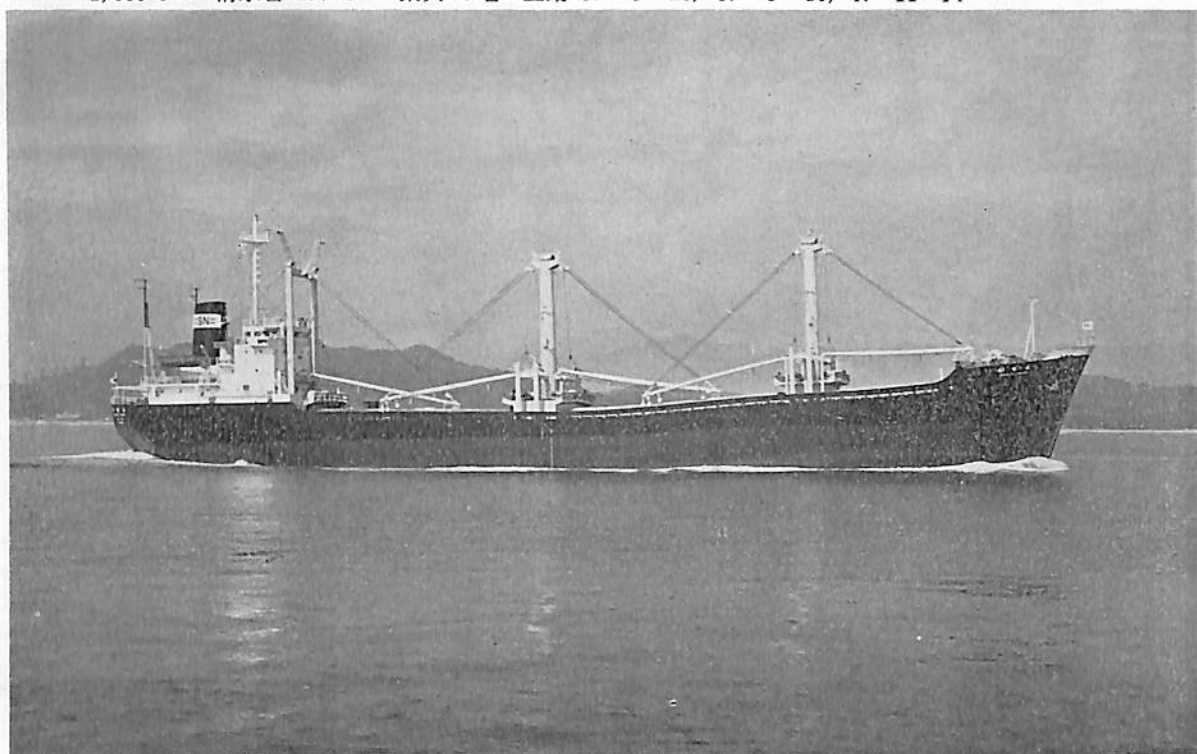
正 竜 丸 (雑貨, 木材運搬船) 船主 松南汽船株式会社 造船所 高知県造船株式会社 総噸数 5,472.06 噸 純噸数 3,618.27 噸 近海 船級 NK 載貨重量 8,725.12 噸 全長 126.20 m 長(垂) 118.00 m 幅(型) 17.10 m 深(型) 9.70 m 吃水 7.713 m 満載排水量 11,817.24 噸 ウェル甲板船 主機 神戸発動機 6 UEC 52/105 D型ディーゼル機関 1 基 出力 5,270 PS×166 RPM 燃料消費量 17.7 t/d 航続距離 13,760 海里 速力 14.4 ノット 貨物倉(ベール) 11,362.80 m 3 (グレーン) 12,464.16 m 3 燃料油倉 786.67 m 3 清水倉 470.00 m 3 乗員 35 名 工期 47-6-20, 47-9-8, 47-11-20
