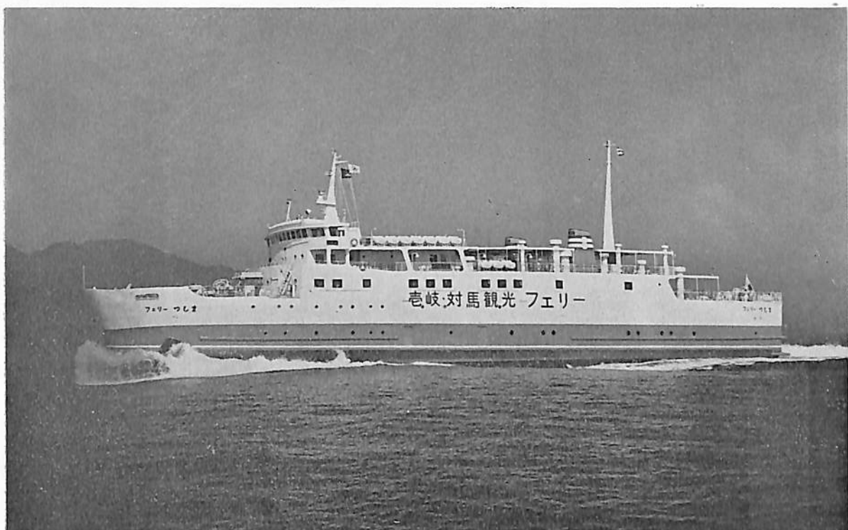
フェリー つしま (自動車航送客船) 船主 船舶整備公団, 九州郵船株式会社 造船所 内海造船株式会社 総噸数 1,575.61 噸 純噸数 597.03 噸 沿海 船級 JG 載貨重量 566.44 噸 全長 76.110 m 長(垂) 69.000 m 幅(型) 14.000 m 深(型) 4.800 m 吃水 3.820 m 満載排水量 2,049 噸 平甲板船 主機 ダイハツ 8 DSM-26 型 (4 機 2 軸) 出力 2×2,720 PS×682/270 RPM 燃料消費量 23.4 t/d 航続距離 1,267 海里 速力 17.6 ノット 旅客 980 名 搭載車 8 tトラック 17 台, 乗用車 2 台 燃料油倉 75.77 m 3 清水倉 50.46 m 3 乗員 33 名 工期 47-2-25, 47-7-13, 47-10-27
