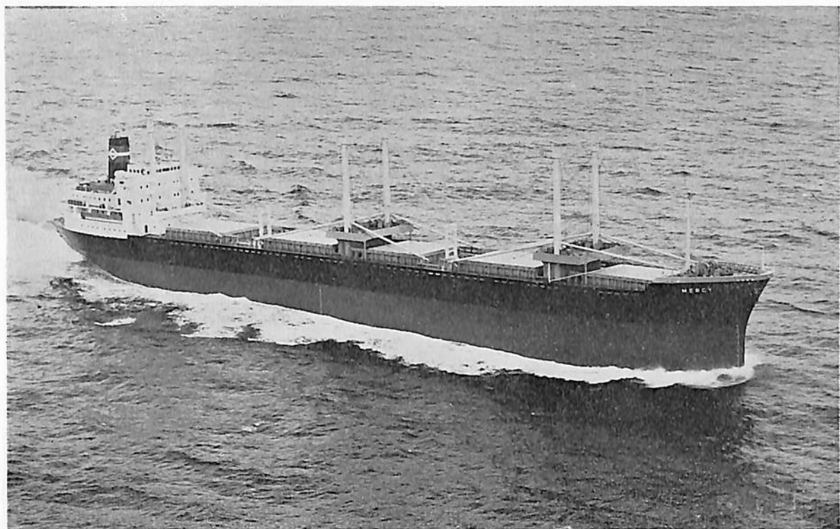
MERCY (ばら積貨物船) 船主 Safety Company Ltd. (リベリア) 造船所 日立造船・舞鶴工場 総噸数 14,783.20 噸 純噸数 9,959 噸 遠洋 船級 AB 載貨重量 26,041 噸 全長 172.883 m 長(垂) 164.00 m 幅(型) 22.80 m 深(型) 14.35 m 吃水 10.2675 m 満載排水量 32,122 噸 一層甲板型 主機 日立 B&W 8 K 62 EF 型ディーゼル機関 1 基 出力 9,800 PS×140 RPM 航続距離 16,200 海里 速力 15.0 ノット 貨物倉 (ベール) 32,352.14 m 3 (グリーン) 33,326.94 m 3 燃料油倉 1,856.64 m 3 清水倉 494.79 m 3 乗員 42 名 工期 47-3-2, 47-5-24, 47-10-10 同型船 ISLAND SUN
