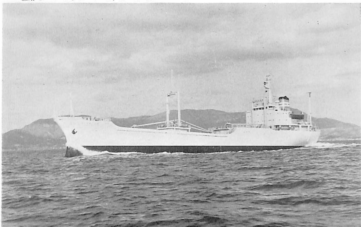
第一日本ハム丸 (冷凍運搬船) 船主 泰光海運株式会社 造船所 四国ドック株式会社 総噸数 2,919.31 噸 純噸数 1,707.56 噸 遠洋 船級 NK 載貨重量 4,321.14 噸 全長 109.00 m 長(垂) 100.00 m 幅(型) 15.50 m 深(型) 8.00 m 吃水 6.716 m 満載排水量 6,524.20 噸 凹甲板船尾機関型 主機 神発 7 UET 52/900 型 ディーゼル機関 1 基 出力 5,520 PS×188 RPM 燃料消費量 A 2.0 t/d C 21.2 t/d 航続距離 12,900 海里 速力 16.60 ノット 貨物倉(ベール) 4,726.4 m 3 燃料油倉 998.1 m 3 清水倉 197.3 m 3 乗員 29 名 工期 47-8-9, 47-9-26, 47-11-29
