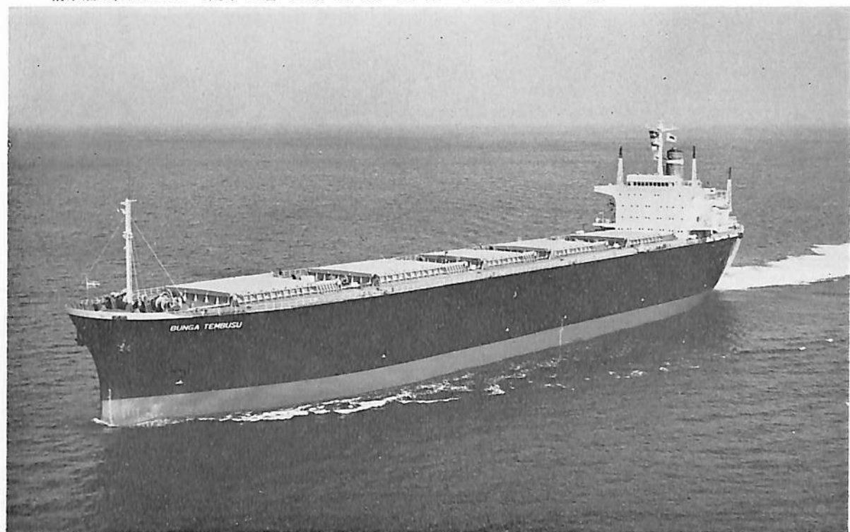
BUNGA TEMBUSU（チップ運搬船） 船主 Malaysian Internatioual Shipping Corp. 造船所 住友重機 工業株式会社 総噸数 32,347.73 噸 純噸数 25,431.98 噸 遠洋 船級 LR 載貨重量 32,725 噸 全長 196.00 m 長(垂) 188.00 m 幅(型) 29.40 m 深(型) 20.80 m 吃水 9.70 m 満載排水量 41,651 噸 平甲板型 主機 住友ス ルザー 7 RD 76 型ディーゼル機関 1 基 出力 9,520 PS×116 RPM 燃料消費量 37.2 t/d 航続距離 13,000 海里 速力 15.05 ノット 貨物倉(グレーン) 77,606 m 3 燃料油倉 1,607 m 3 清水倉 437 m 3 乗員 51 名 工期 47-4 -13, 47-7-21, 47-11-21
