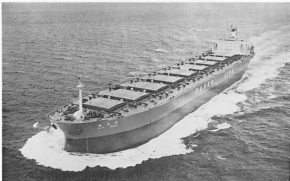
鯉 光 丸 (ばら積貨物船) 船主 三光汽船株式会社 造船所 三菱重工業・広島造船所 総噸数 68,202.62 噸 純噸数 45,090.66 噸 遠洋 船級 NK 載貨重量 122,544 噸 全長 261.00 m 長(垂) 247.00 m 幅(型) 40.60 m 深(型) 24.00 m 吃水 16.80 m 凹甲板型 主機 三菱スルザー 9RND90 型ディーゼル機関 1 基 出力 23,490 PS×118 RPM 燃料消費量 86.3 t/d 航続距離 27,000 海里 速力 15.6 ノット 貨物倉(グレン) 140,217.5 m 3 燃料油倉 7,302 m 3 清水倉 592.3 m 3 乗員 35 名 工期 47-5-18, 47-8-17, 47-11-30 同型船 ジャパン アカシア
