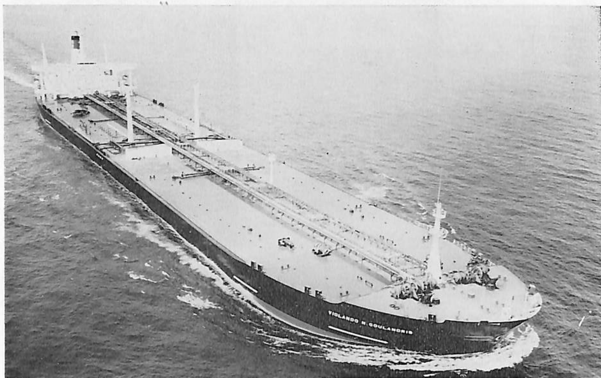
VIOLANDO N. GOULANDRIS (油槽船) 船主 Ocean Marine Transport Ltd., (リベリア) 造船所 日本鋼管・津造船所 総噸数 119,811.21 噸 純噸数 101,690.51 噸 遠洋 船級 LR 載貨重量 258,173 噸 全長 338.1 m 長(垂) 320.0 m 幅(型) 51.8 m 深(型) 26.7 m 吃水 20.898 m 満載排水量 294,517 噸 船首 楼付平甲板船 主機 三菱 MS-32 型タービン 1 基 出力 31,000 PS×85 RPM 燃料消費量 202.8 g/ps-h 航続距離 24,900 海里 速力 15.08 ノット 貨油倉 312,932.0 m 3 燃料油倉 11,204.1 m 3 清水倉 710.9 m 3 乗員 62 名 工期 47-4-3, 47-7-28, 47-11-3
