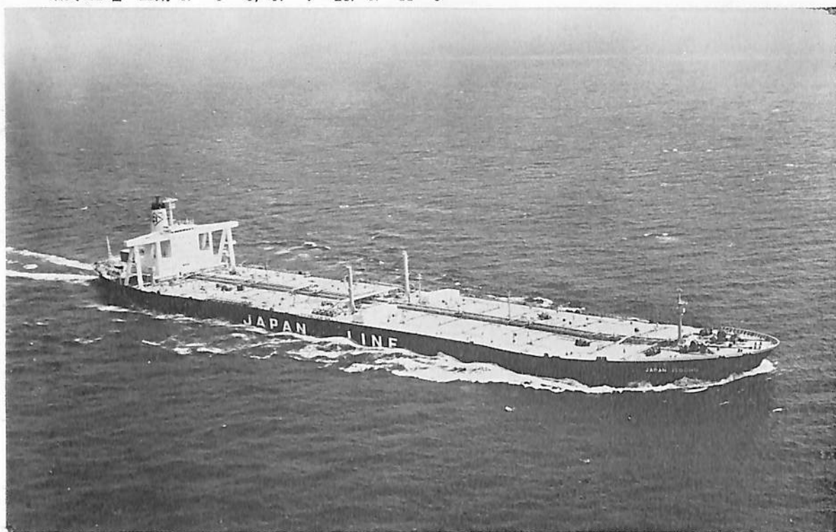
JAPAN ITOCHU (油槽船) 船主 Companhia Internationale Juntra Tankers S.A (パナマ) 造船所 川崎重工業・坂出工場 総噸数 105,074.28 噸 純噸数 88,780.05 噸 遠洋 船級 NK 載貨重量 232,727 噸 全長 319.30 m 長(垂) 305.00 m 幅(型) 53.00 m 深(型) 25.30 m 吃水 19.6065 m 満載排水量 267,243 噸 船首 楼付平甲板船 主機 川崎 UA-360 型船用タービン 1 基 出力 35,000 PS×89 RPM 燃料消費量 174.8 t/d 航続距離 15,100 海里 速力 15.77 ノット 燃料油倉 8,060.08 m 3 清水倉 203.57 m 3 乗員 36 名 工期 47-12-14, 47-5-12, 47-9-7
