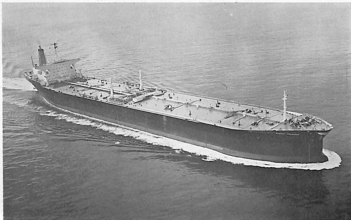
ENERGY CREATION (油槽船) 船主 Eastern Tankers, Inc. (リベリア) 造船所 佐世保重工業・佐世 造船所 全長 327.00 m 長(垂) 313.00 m 幅(型) 48.20 m 深(型) 25.50 m 吃水 20.021 m 総噸数 103,135.93 噸 載貨重量 220,398 噸 速力(試) 16.83 ノット (航) 16.18 ノット 主機 IHI 船用タービン 1 基 出力(最大) 33,000 PS 船級 LR 工期 47-5, 47-7, 47-11-14
