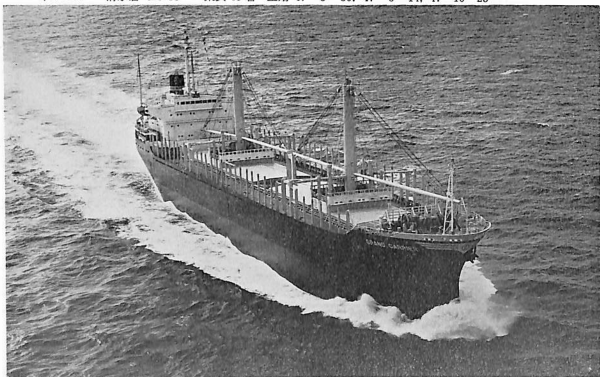
GRAND CARRIER (木材兼ばら積貨物船) 船主 Grand Carriers Incorporated (リベリア) 造船所 株式 会社 金指造船所 総噸数 10,527.54 噸 純噸数 6,534.86 噸 遠洋 船級 LR 載貨重量 19,306.34 噸 全長 155.10 m 長(垂) 146.00 m 幅(型) 22.80 m 深(型) 12.65 m 吃水 9.338 m 満載排水量 24,383.29 噸 凹甲 板船 主機 三井 B&W 7K 62 EF 型ディーゼル機関 1 基 出力 8,600 PS×104 RPM 燃料消費量 33.7 t/d 航続 距離 13,500 海里 速力 14.7 ノット 貨物倉(ベール) 22,062.99 m 3 (グレーン) 23,013.94 m 3 燃料油倉 A 170.01 m 3 C 1,501.71 m 3 清水倉 456.46 m 3 乗員 43 名 工期 47-4-17, 47-8-10, 47-11-16
