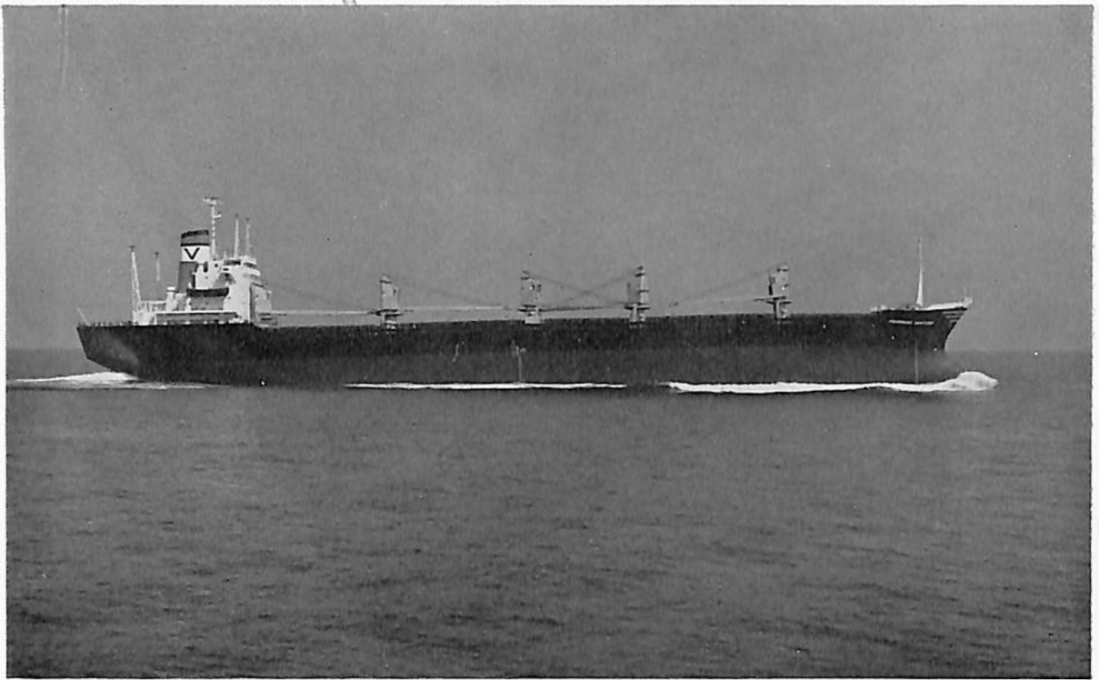
FOURSEAS VENTURE (ばら積貨物船) 船主 Dah Wah Shipping Co., Ltd. (ホンコン) 造船所 株式会社 臼杵鉄工所・佐伯造船所 総噸数 14,764.70 噸 純噸数 10,217.65 噸 遠洋 船級 LR 載貨重量 26,503 噸 全長 166.07 m 長(垂) 156.00 m 幅(型) 24.80 m 深(型) 14.35 m 吃水 10.456 m 満載排水量 33,054 噸 凹甲板 型 主機 IHI-スルザー 6 RND 68 型ディーゼル機関 1 基 出力 8,415 PS×142 RPM 燃料消費量 154 g/ps.h +3% 航続距離 13,500 海里 速力 14.40 ノット 貨物倉(ペール) 32,444.95 m 3 (グレーン) 33,432.06 m 3 燃料油倉 1,639.90 m 3 清水倉 252.27 m 3 乗員 46 名 工期 47-4-15, 47-9-11, 47-11-9
