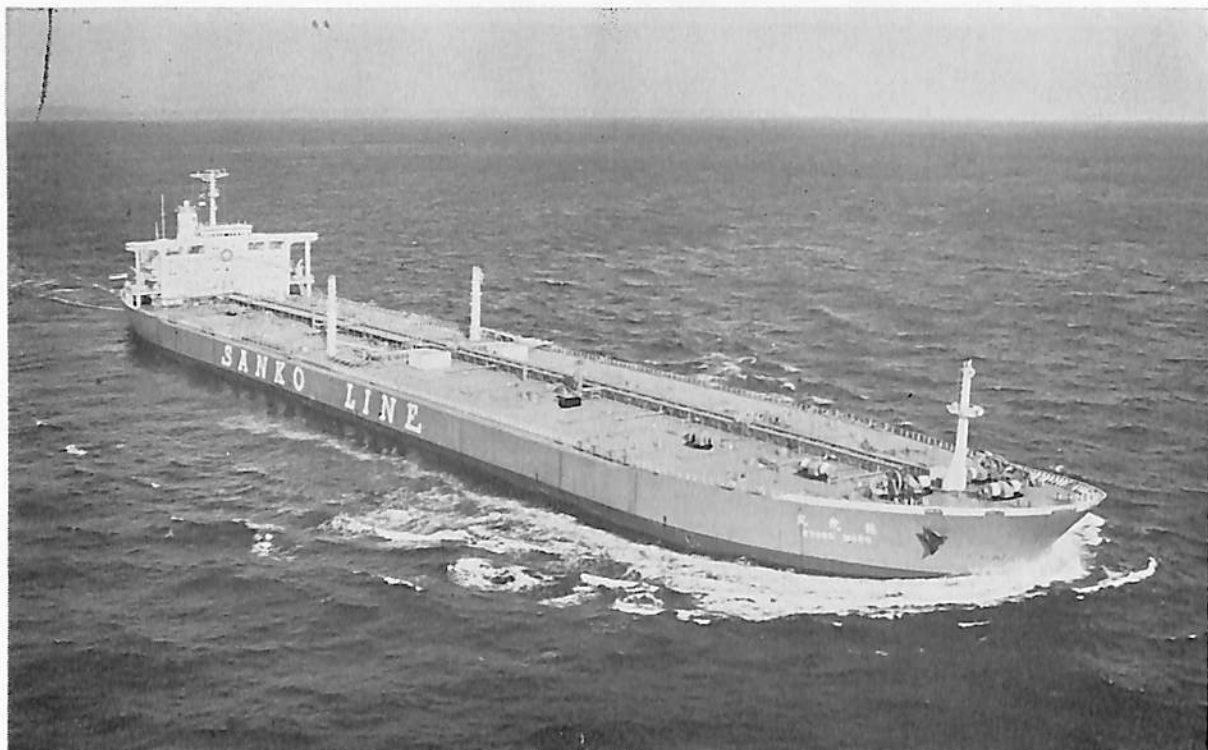
龍 光 丸 (油 槽 船) 船 主 三 光 汽 船 株 式 会 社 造 船 所 石 川 島 播 磨 重 工 業 ・ 横 浜 造 船 所 総噸数 116,757.56 噸 純噸数 85,240.08 噸 遠洋 船級 NK 載貨重量 228,646Lt 全長 317.00 m 長(垂) 300.00 m 幅(型) 50.00 m 深(型) 27.00 m 吃水 20.733 m 平甲板船 主機 IHI-クロスコンパウンド型衝動式船用 タービン 1 基 出力 33,000 PS×80 RPM 燃料消費量 159.75 t/d 航続距離 16,605 海里 速力 16.4 ノット 汽罐 IHI-MDM 型×2 61.2 kg/cm 2 G×515° C×72 t/h 貨油倉 278,849.7 m 3 燃料油倉 8,615.9 m 3 清水倉 369.1 m 3 乗員 44 名 工期 47-3-14, 47-9-15, 47-12-12 M0 取得船 IHI イナートガスシステム装置, 固 定式タンククリーニングマシンを全タンクに装置
