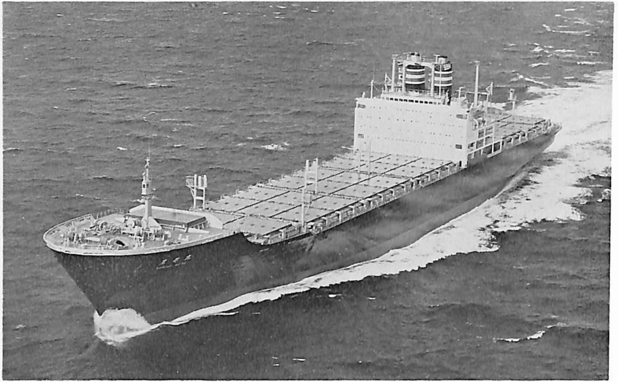
黒部丸 (コンテナ船) 船主 日本郵船株式会社 造船所 三菱重工業・神戸造船所 総噸数 37,845.77 噸 純噸数 22,336.52 噸 遠洋 船級 NK 載貨重量 32,343 噸 全長 260.457 m 長(垂) 242.00 m 幅(型) 32.20 m 深(型) 19.60 m 吃水 11.54 m 満載排水量 54,428 噸 長船首楼付平甲板型 主機 三菱スルザー12 RND 90 型ディーゼル機関 2 基 出力 2 \times 29,600 PS \times 116 RPM 燃料消費量 220 t/d 航続距離 約 20,000 海里 速力 25.65 ノット コンテナ搭載数 20' にて 1,826 箇 燃料油倉 8,266.9 m 3 清水倉 413.4 m 3 乗員 33 名 工期 47-1-6, 47-7-12, 47-12-11 M0 取得船, NNSS 装備, 操舵室に遠隔監視用 ITV 2 台, Tar Epoxy, Pure Epoxy 塗装
