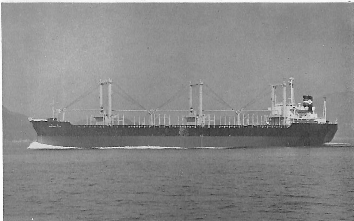
EASTERN LILAC (木材兼ばら積貨物船) 船主 Liberian Lilac Transports, Inc. (リベリア) 造船所 笠戸船渠株式会社 総噸数 17,715.58 噸 純噸数 12,033 噸 遠洋 船級 AB 載貨重量 34,196 噸 全長 185.50 m 長(垂) 175.00 m 幅(型) 27.00 m 深(型) 15.30 m 吃水 11.012 m 満載排水量 42,170 噸 凹甲板船 主機 住友スルザー 7 RND 68 型ディーゼル機関 1 基 出力 9,818 PS×142 RPM 燃料消費量 37.8 t/d 航続距離 14,300 海里 速力 14.5 ノット 貨物倉(ベール) 40,866.99 m 3 (グリーン) 41,962.44 m 3 燃料油倉 1,696.44 m 3 清水倉 440.16 m 3 乗員 48 名 工期 47-6-7, 47-9-8, 47-12-13
