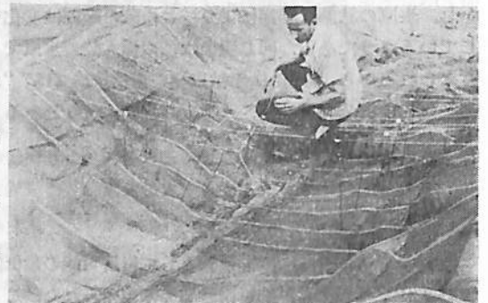
図11 トリニダッド局の模型によるアンテナ・アース系の測定試験
