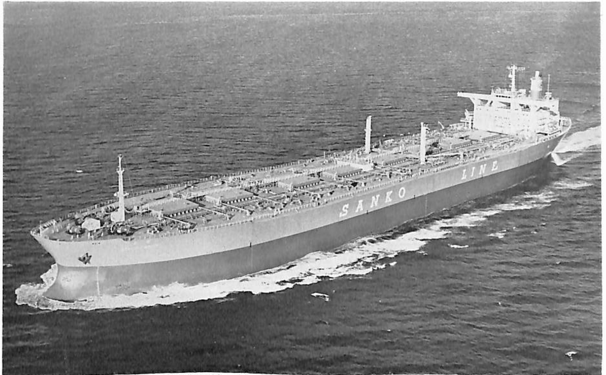
EASTERN SPRIT (鉱石兼油運搬船) 船主 Lihirian Thrush Transport Inc. (リベリア) 造船所 三菱重工業・横浜造船所 総噸数 85,564.50 噸 純噸数 66,840.53 噸 遠洋 船級 NK 載貨重量 164,744 噸 全長 294.95 m 長(垂) 280.00 m 幅(型) 47.40 m 深(型) 24.80 m 吃水 17.50 m 平甲板型 主機 三菱ウエスチングハウス型タービン 1 基 出力 28,000 PS×88 RPM 燃料消費量 139 t/d 航続距離 28,400 海里 速力 16.0 ノット 貨物倉(グリーン) 94,999 m 3 貨油倉 507,477 m 3 燃料油倉 11,777 m 3 清水倉 526 m 3 乗員 40 名 工期 47-4-11, 47-8-22, 47-12-27 同型船 CYPRESS KING 設備 イナートガスシステム, 機関室操舵室エレベータ装置
