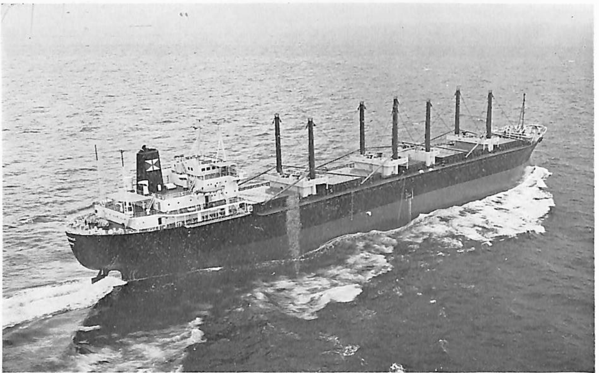
ERRADALE (ばら積貨物船) 船主 John Swire & Sons Ltd.(リベリア) 造船所 株式会社 大阪造船所 総噸数 20,239.11 噸 純噸数 13,408.08 噸 遠洋 船級 AB 載貨重量 34,054 噸 全長 185.500 m 長(垂) 175.000 m 幅(型) 26.000 m 深(型) 15.500 m 吃水 11.151 m 満載排水量 41,748 噸 凹甲板船 主機 IHI スルザー 7 RND 68 型ディーゼル機関 1 基 出力 10,395 PS×144.8 RPM 燃料消費量 約 42.03 t/d 航続距離 約 16,110 海里 速力 14.6 ノット 貨物倉(ベール) 41,242 m 3 (グレーン) 44,735 m 3 燃料油倉 2,164.9 m 3 清水倉 432.4 m 3 乗員 45 名 工期 47-6-19, 47-9-19, 47-12-12
