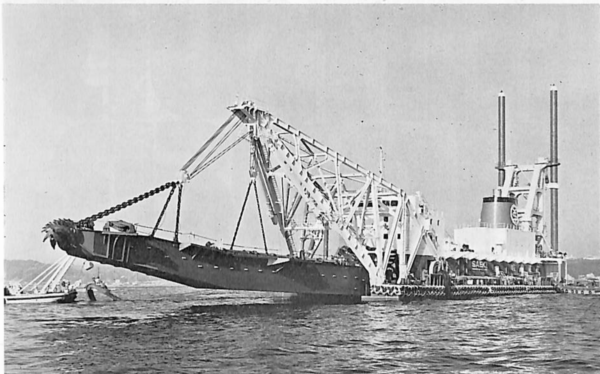
日 徳 丸 (浚 渫 船) 船 主 佐伯建設工業株式会社 造船所 住友重機械工業・浦賀造船所 長さ(垂線間) 75.60 m 幅(型) 20.00 m 深さ(型) 5.30 m 計画平均型吃水 約 3.70 m 浚渫ポンプ駆動用原動機 9,200馬力衝動式蒸気タービン 浚渫ポンプ揚水能力 10,500m 3 /h×110m(海水にて) 浚渫深度 約 33 m (ラダーアングル45°にて) 排送距離 約 5,000 m 管径 吸入管(内径) 900mm, 排送管(内径) 760~840mm 工期 47-6-21, 47-8-26, 47-12-19
