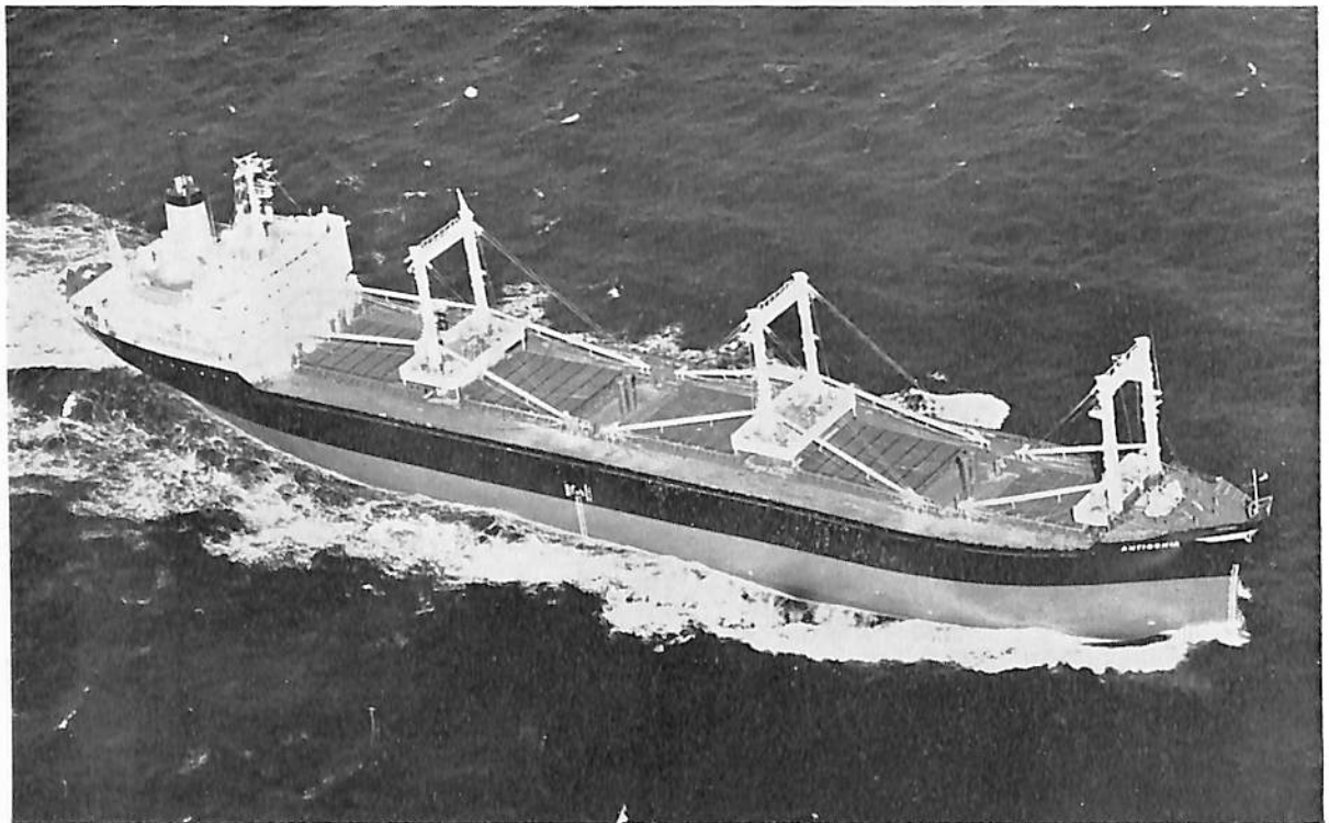
ANTIOCHIA (ばら積貨物船) 船主 Pedregal Compania Naviera S. A.(パナマ) 造船所 日立造船・ 向島工場 総噸数 11,931.19 噸 純噸数 7,730 噸 遠洋 船級 AB 載貨重量 19,198 噸 全長 156.16 m 長(垂) 146.00 m 幅(型) 22.60 m 深(型) 12.90 m 吃水 9.50 m 満載排水量 24,197 噸 一層甲板型 主機 日立 B&W 6 K 62 EF 型ディーゼル機関 1 基 出力 7,600 PS×146 RPM 燃料消費量 約 30 t/d 航続距離 約 15,150 海里 速力 14.85 ノット 汽罐(補) 1,530 kg/h, 8 kg/cm 2 G 貨物倉(ベール) 23,610.24 m 3 (グレーン) 24,303.57 m 3 燃料油倉 1,508.76 m 3 清水倉 260.79 m 3 乗員 43 名 工期 47-7-3, 47-9-28, 47-12-14 同型船 ORESTIA, OLYNTHIA
