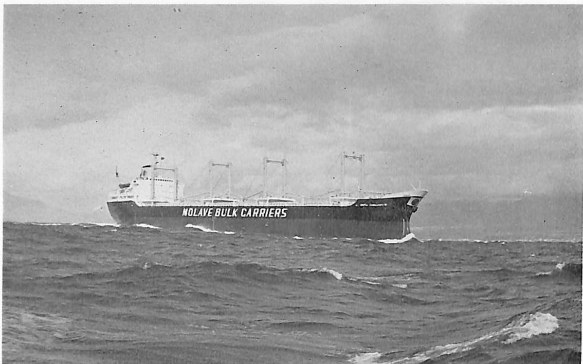
DONA CORAZON II (ばら積貨物船) 船主 Molave Bulk Carriers Inc. (フィリピン) 造船所 函館ドック・室蘭製作所 総噸数 15,892.02 噸 純噸数 11,632.58 噸 遠洋 船級 AB 載貨重量 28,757 Lt 全長 180.80 m 長(垂) 170.00 m 幅(型) 23.10 m 深(型) 14.50 m 吃水 35'-0" 満載排水量 35,217 噸 船首尾楼付一層甲板船 主機 IHI スルザー 6RND 76 型ディーゼル機関 1 基 出力 10,800 PS×117.8 RPM 燃料消費量 41.5 t/d 航続距離 16,000 海里 速力 15.0 ノット 貨物倉(ベール) 1,160.175 ft 3 (グレーン) 1,270.299 ft 3 燃料油倉 C 71,831 ft 3 A 6,480 ft 3 清水倉 7,450 ft 3 乗員 47 名 工期 47-6-14, 47-9-14, 47-11-28
