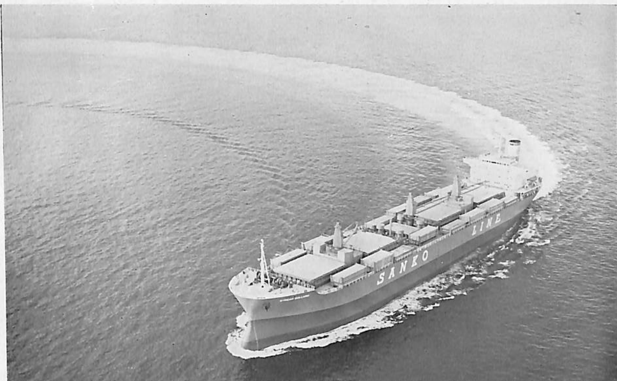
STREAM BOLLARD (自動車兼ばら積貨物船) 船主 Bollard Corporation (リベリア) 造船所 株式会社 大阪造船所 総噸数 20,538.66 噸 純噸数 14,486 噸 遠洋 船級 AB 載貨重量 33,025 噸 全長 185.371 m 長 (垂) 175.00 m 幅(型) 26.00 m 深(型) 16.10 m 吃水 11.385 m 満載排水量 42,732 噸 凹甲板船 主機 IHI スルザー 6 RND 76 型ディーゼル機関 1 基 出力 10,800 PS×117.8 RPM 燃料消費量 43.25 t/d 航続距離 15,600 海里 速力 14.8 ノット 貨物倉(ベール) 40,088 m 3 (グリーン) 41,396 m 3 燃料油倉 2,137.9 m 3 清水倉 465 m 3 乗員 38 名 工期 47-8-3, 47-10-26, 48-1-17 設備 自動車積載装置として吊下げ式及び 取外し式自動車甲板を No. 1, 2, 4, 5 Hold に装備。
