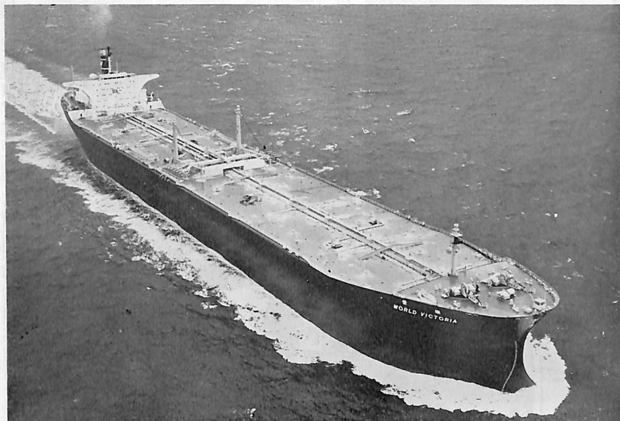
WORLD VICTORIA (油槽船) 船主 Liberian Firmity Trnsparts, Inc. (リベリア) 造船所 佐世保 重工業・佐世保造船所 全長 326.00 m 長(垂) 313.00 m 幅(型) 48.20 m 深(型) 25.50 m 吃水 20.015 m 総噸数 110,061.75 噸 載貨重量 221,929 噸 速力(公試) 16.53 ノット (航) 16.13 ノット 主機 川崎 UA タービン 1 基 出力 33,000 PS 船級 LR 工期 47—7, 47—10, 48—2—2
