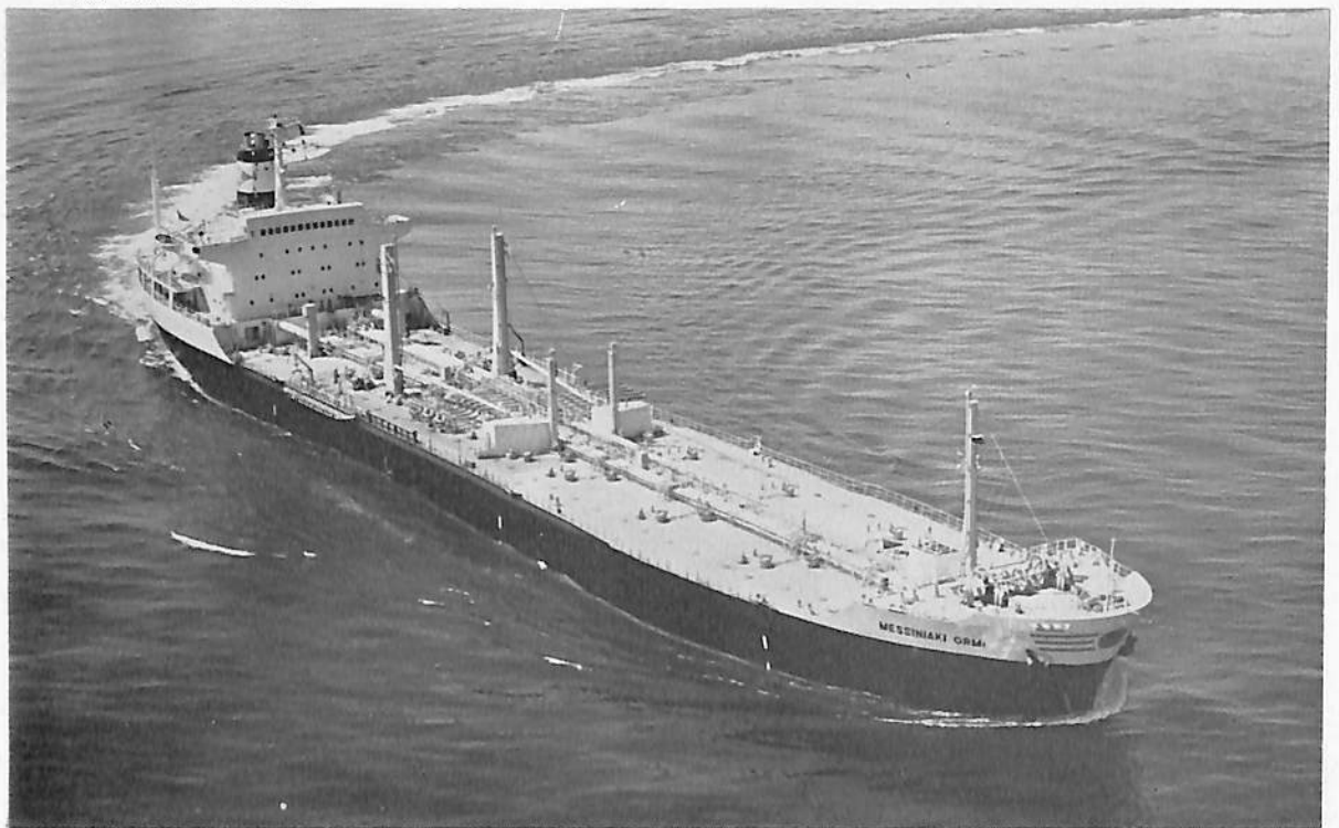
MESSINIAKI ORMI (油槽船) 船主 Estrella Dinamica Navigacion (パナマ) 造船所 石川島播磨重 工・相生工場 総噸数 17,354.80 噸 純噸数 11,901.44 噸 遠洋 船級 LR 載貨重量 30,293 噸 全長 170.688 m 長(垂) 162.00 m 幅(型) 26.00 m 深(型) 14.35 m 吃水 11.006 m 凹甲板船 主機 IHI スルザー 7 RND 68 型ディーゼル機関 1 基 出力(連続最大) 11,550 PS \times 150 \text{ RPM} (常用) 10,400 PS \times 144.8 \text{ RPM} 燃料消費量 37.4 t/d 航続距離 23,200 海里 速力(試) 16.44 ノット (航) 15.75 ノット 貨油倉 1,787.0 m 3 燃料油倉 C 2,506.7 m 3 A 222.2 m 3 清水倉 481.0 m 3 乗員 41 名 工期 47-2-2, 47-4-25, 47-9
