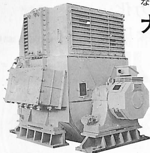
交流発電機 1100KVA 450V 600RPM
