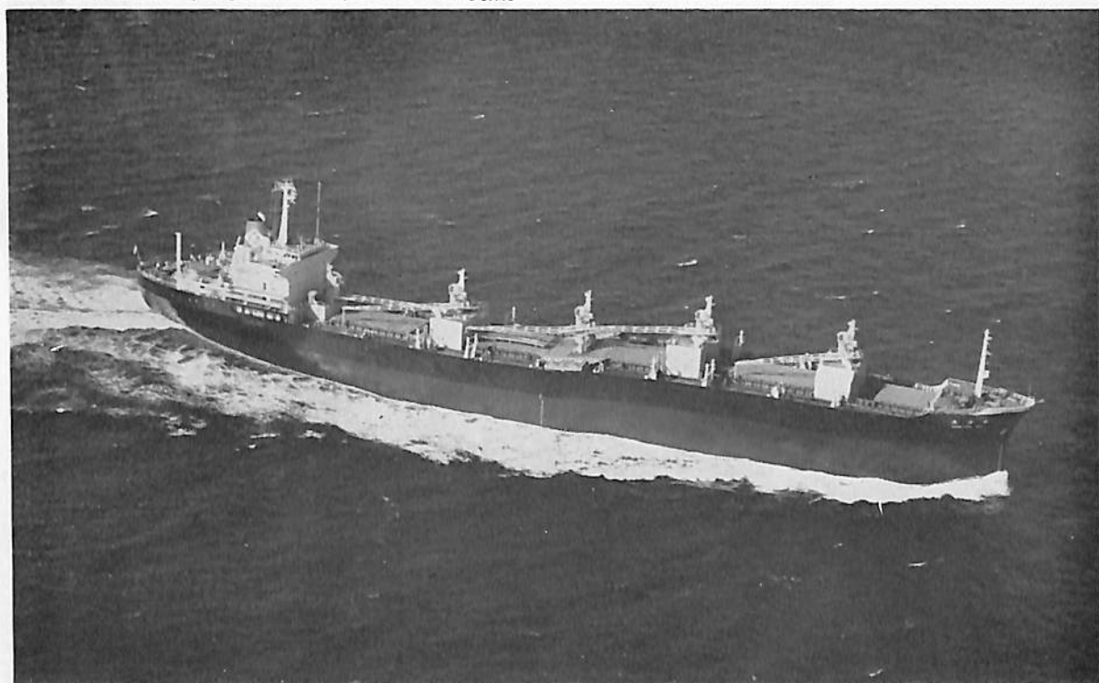
金 寿 丸 (自動車兼ばら積貨物船) 船主 金成汽船株式会社 造船所 株式会社 金指造船所 総噸数 18,201.20 噸 純噸数 10,962.79 噸 遠洋 船級 NK 載貨重量 27,852.57 噸 全長 179.01 m 長(垂) 168.00 m 幅(型) 25.40 m 深(型) 15.00 m 吃水 10.900 m 満載排水量 36,521.49 噸 凹甲板型 主機 三井 B&W 6 K 74 EF 型ディーゼル機関 1 基 出力 9,860 PS×117.5 RPM 燃料消費量 38.4 t/d 航続距離 16,000 海里 速力 15.3 ノット 貨物倉(ベール) 31,288.96 m 3 (グリーン) 32,401.07 m 3 燃料油倉 A 140.96 m 3 C 1,735.25 m 2 清水倉 886.04 m 3 乗員 33 名(外 1 名) 工期 47-6-29, 47-10-18, 48-1-23
