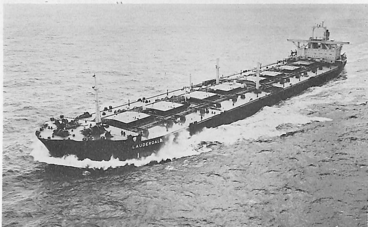
LAUDERDALE (鉾油兼用船) 船主 The Peninsular & Oriental Steam Navigation Co. (英) 造船所 三菱重工業・長崎造船所 総噸数 143,959.18 噸 純噸数 111,557.18 噸 遠洋 船級 LR 載貨重量 264,591 噸 全長 335.66 m 長(垂) 320.00 m 幅(型) 35.60 m 深(型) 27.50 m 吃水 20.6155 m 船首楼付平甲板船 主機 三菱コンパウンド型タービン1基 出力 32,000 PS×90 RPM 燃料消費量 約 161 t/d 航統距離 約 24,000 海里 速力 15.05 ノット 貨物倉(グリーン) 154,551.5 m 3 貨油倉 318,855.5 m 3 燃料油倉 13,627.5 m 3 清水倉 578.40 m 3 乗員 55 名(外 3 名) 工期 47-3-25, 47-7-25, 47-12-12 同型船 NAESS AMPASAOOR
