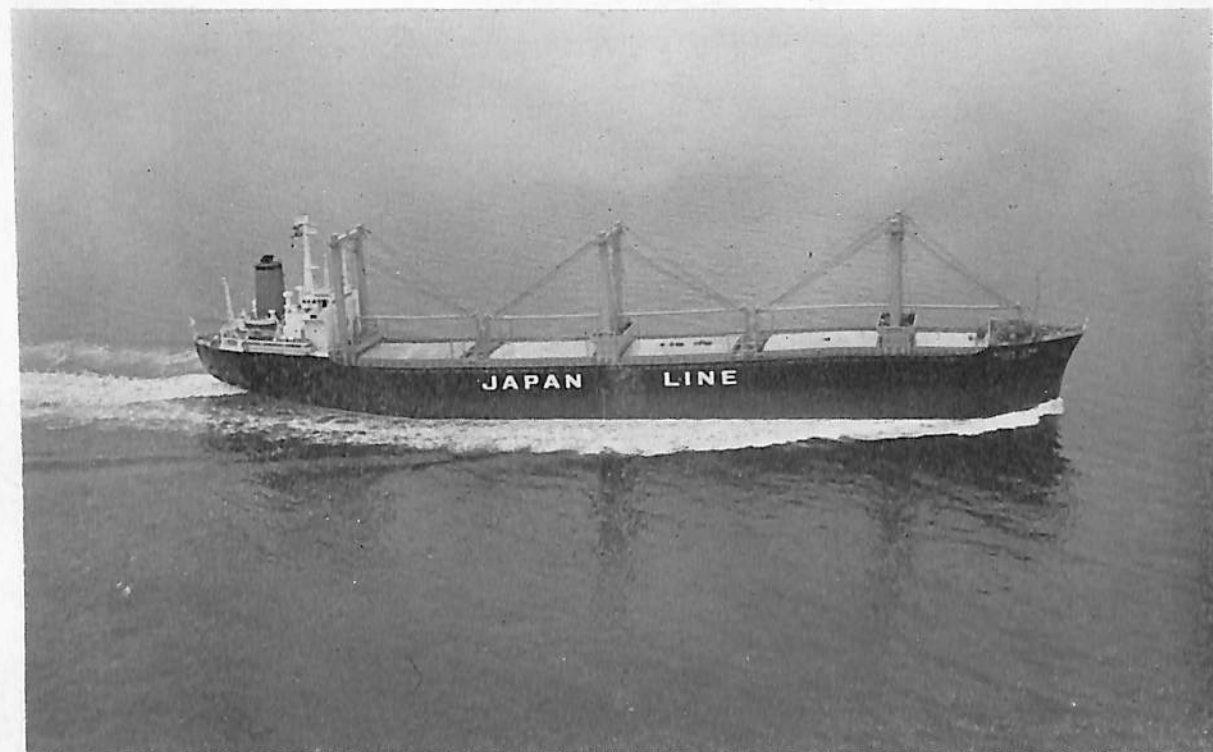
ジャパンブラム (ばら積兼木材運搬船) 船主 株式会社 パシフィックリース 造船所 常石造船株式会社 総噸数 16,456.18 噸 純噸数 10,414.81 噸 遠洋 船級 NK 載貨重量 24,549 噸 全長 175.20 m 長(垂) 165.00 m 幅(型) 25.00 m 深(型) 14.00 m 吃水 9.8225 m 満載排水量 31,594 噸 凹甲板船 主機 IHI スルザー 6 RND 68 型ディーゼル機関 1 基 出力 8,415 PS×142 RPM 燃料消費量 32.1 t/d 航続距離 14,000 海里 速力 14.8 ノット 貨物倉(ベール) 34,390.3 m 3 (グリーン) 35,085.2 m 3 燃料油倉 F 1,565.0 m 3 D 264.5 m 3 清水倉 401.2 m 3 乗員 33 名 (外 2 名) 工期 47-3-8, 47-5-12, 47-9-14
