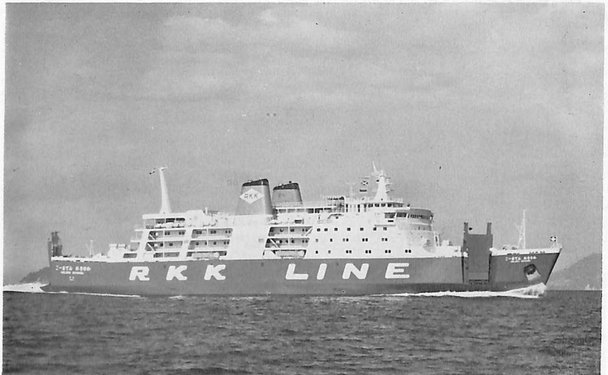
こーるでん おきなわ (貨客船) 船主 琉球海運株式会社 造船所 尾道造船株式会社 総噸数 7,604.21 噸 純噸数 3,812.16 噸 近海 船級 NK 載貨重量 2,474.35 噸 全長 126.07 m 長(垂) 118.00 m 幅(型) 22.00 m 深(型) 13.20 m 吃水 5.75 m 満載排水量 7,705.12 噸 覆甲板型, 傾斜型船首 主機 三菱 MAN V7V 40/54 型ディーゼル機関 1 基 出力 6,840 PS×391/193 RPM 燃料消費量 49.0 t/d 航続距離 2,650 海里 速力 20.20 ノット 貨物倉(ペール) 10,443.12 m 3 燃料油倉 298.38 m 3 清水倉 494.43 m 3 乗員 53 名 工期 47-5-8, 47-9-8, 47-12-15 乗用車 57 台, トラック 11 台, コンテナ搭載設備, フィ ンスタビライザー(スペリー社製) 装備
