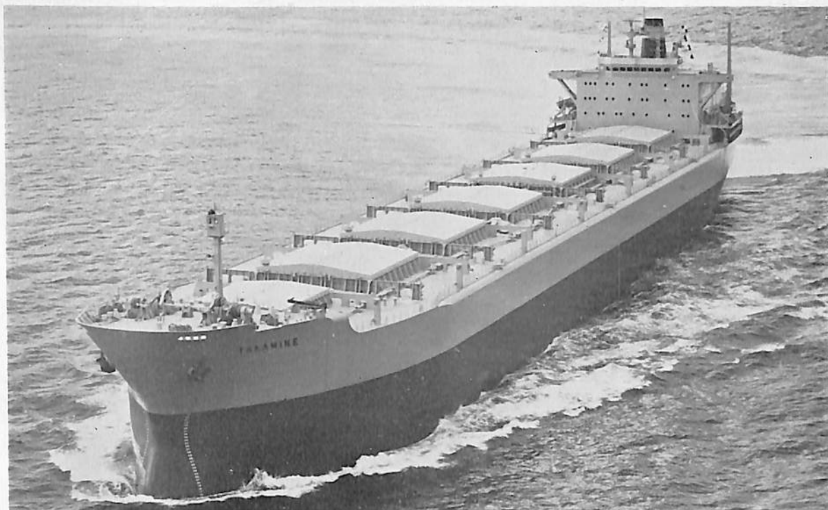
TAKAMINE (ばら積貨物船) 船主 Wilh. Wilhelmsen 系列 9 社 (ノルウェー) 造船所 三菱重工業・神戸造船所 総噸数 36,264.61 噸 純噸数 23,302.43 噸 速洋 船級 NV 載貨重量 63,423 噸 全長 224.00 m 長(垂) 211.28 m 幅(型) 31.80 m 深(型) 18.35 m 吃水 13.345 m 満載排水量 75,315 噸 船首楼付平甲板型 主機 三菱スルザー 7 RND 76 型ディーゼル機関 1 基 出力 12,600 PS×118 RPM 燃料消費量 47.8 t/d 航続距離 22,000 海里 速力 14.6 ノット 貨物倉(グレーン) 76,315.00 m 3 燃料油倉 3,505.1 m 3 清水倉 543.8 m 3 乗員 35 名 工期 47-5-10, 47-9-29, 48-1-27 同型船 TAKASAGO, TAKACHIHO
