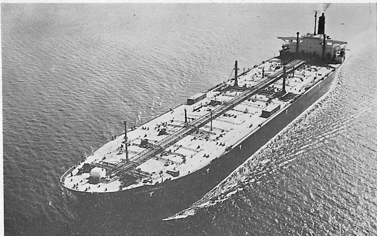
UNIVERSE PIONEER (油槽船) 船主 Universe Tankship Inc. (リベリア) 造船所 石川島播磨重工業・ 呉造船所 総噸数 117,246.34 噸 純噸数 97,576 噸 遠洋 船級 AB 載貨重量 258,484 噸 全長 336.34 m 長(垂) 320.00 m 幅(型) 54.50 m 深(型) 26.00 m 吃水 66'-6 3 / 4 " 平甲板船 主機 IHI Cross-Compound Impulse タービン 1 基 出力(連続最大) 40,000 PS×83 RPM (常用) 36,000 PS×80 RPM 燃料消費量 176.8 t/d 航続距離 28,806 海里 速力(試) 17.32 ノット (航) 16.13 ノット 貨油倉 316,202 m 3 燃料油倉 13,906 m 3 清水倉 800 m 3 乗員 56 名(外 4 名) 工期 47-4-26, 47-8-12, 47-12-28
