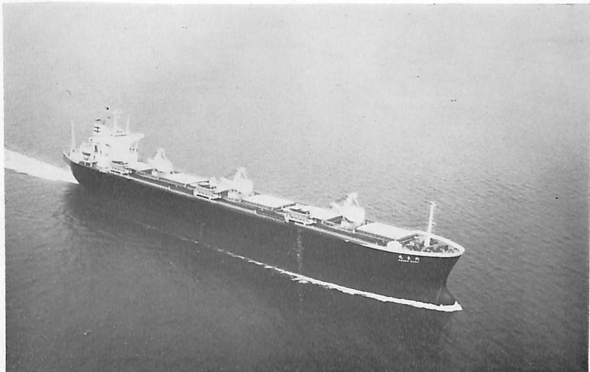
乾 豪 丸 (チップ運搬船) 船主 乾汽船株式会社 造船所 常石造船株式会社 総噸数 40,142.57 噸 純噸数 29,567.34 噸 速洋 船級 NK 載貨重量 47,949 噸 全長 217.01 m 長(垂) 207.00 m 幅(型) 32.20 m 深(型) 20.50 m 吃水 10.6865 m 満載排水量 60,822 噸 平甲板船尾機関 主機 三井 B&W 7 K 47 EF 型ディーゼル機関 1 基 出力 11,900 PS×120 RPM 燃料消費量 47.1 t/d 航続距離 約 12,600 海里 速力 14.9 ノット 貨物倉(ベール) 90,056.7 m 3 (グレーン) 93,832.9 m 3 燃料油倉 F.O 1,858.6 m 3 D.O 142.8 m 3 清水倉 395.1 m 3 乗員 30 名(スベア 4 名含む) 工期 47-4-25, 47-7-5, 47-11-25
