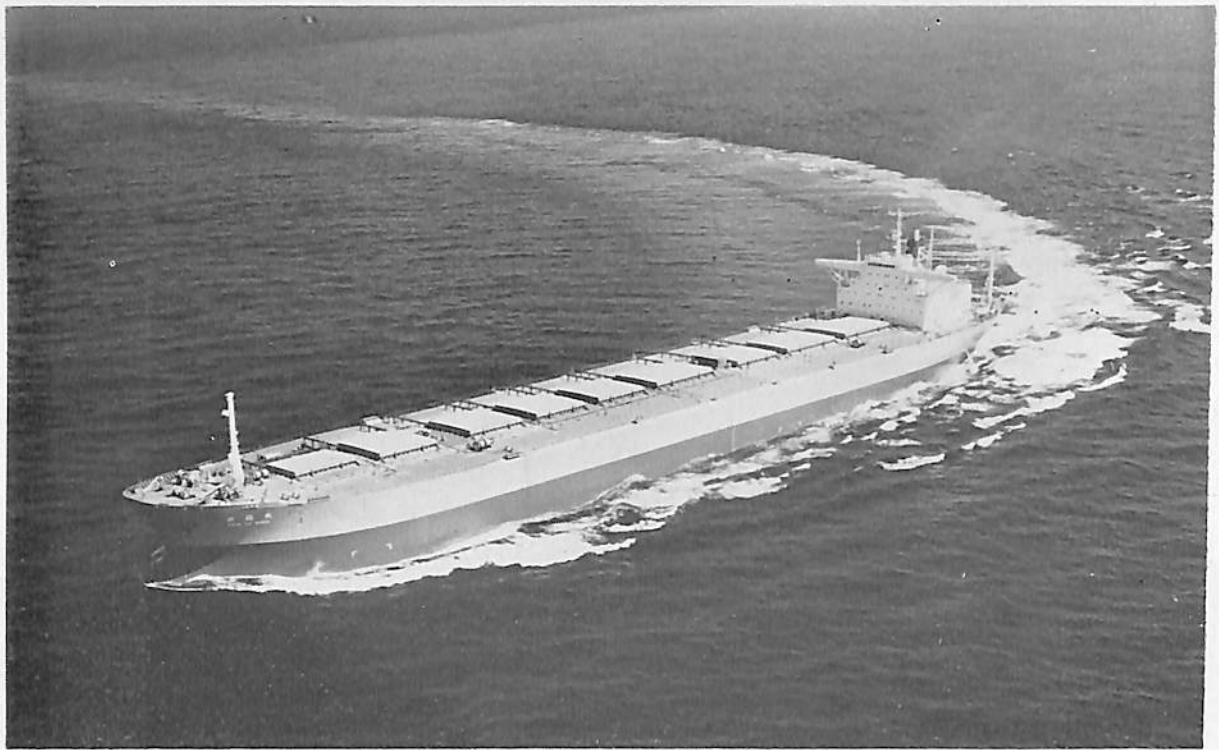
新 雄 丸 (鉱石運搬船) 船主 新和海運株式会社, 万野汽船株式会社 造船所 石川島播磨重工業 相生工場 総噸数 85,383.22 噸 純噸数 28,384.26 噸 遠洋 船級 NK 載貨重量 158,294 噸 全長 281.347 m 長(垂) 269.20 m 幅(型) 44.50 m 深(型) 24.50 m 吃水 17.934 m 平甲板型 主機 IHI スルザー 8RND 105 型ディーゼル機関 1 基 出力 27,200 PS×102.4 RPM 燃料消費量 100.6 t/d 航続距離 38,800 海里 速力 15.80 ノット 貨物倉(グレーン) 89,630.1 m 3 燃料油倉 C 11,601.4 m 3 A 399.2 m 3 清水倉 427.3 m 3 乗員 29 名(外 7 名) 工期 46-12-15, 47-6-20, 47-9-27
