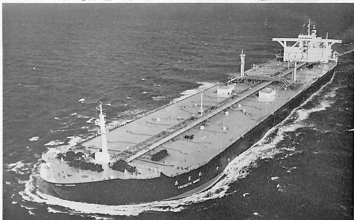
高 宮 丸 (油 槽 船) 船主 出光タンカー株式会社 造船所 三菱重工業・長崎造船所 総噸数 130,608.37 噸 純噸数 94,107.59 噸 遠洋 船級 NK 載貨重量 254,134 噸 全長 336.85 m 長(垂) 320.00 m 幅(型) 53.60 m 深(型) 26.40 m 吃水 19.738 m 船首楼付平甲板船 主機 三菱 MS-36 型船用タービン1基 出力 36,000 PS×90 RPM 燃料消費量 176.3 t/d 航統距離 17,000 海里 速力 15.65 ノット 汽罐 CE V2M-8W 型×2 発電機 AC 450 V, 1,250 KW×1 貨油倉 303,532 m 3 燃料油倉 9,536 m 3 清水倉 428 m 3 乗員 46 名 工期 47-6-7, 47-9-27, 47-12-25 同型船 沖島丸 設備 イナートガスシステム
