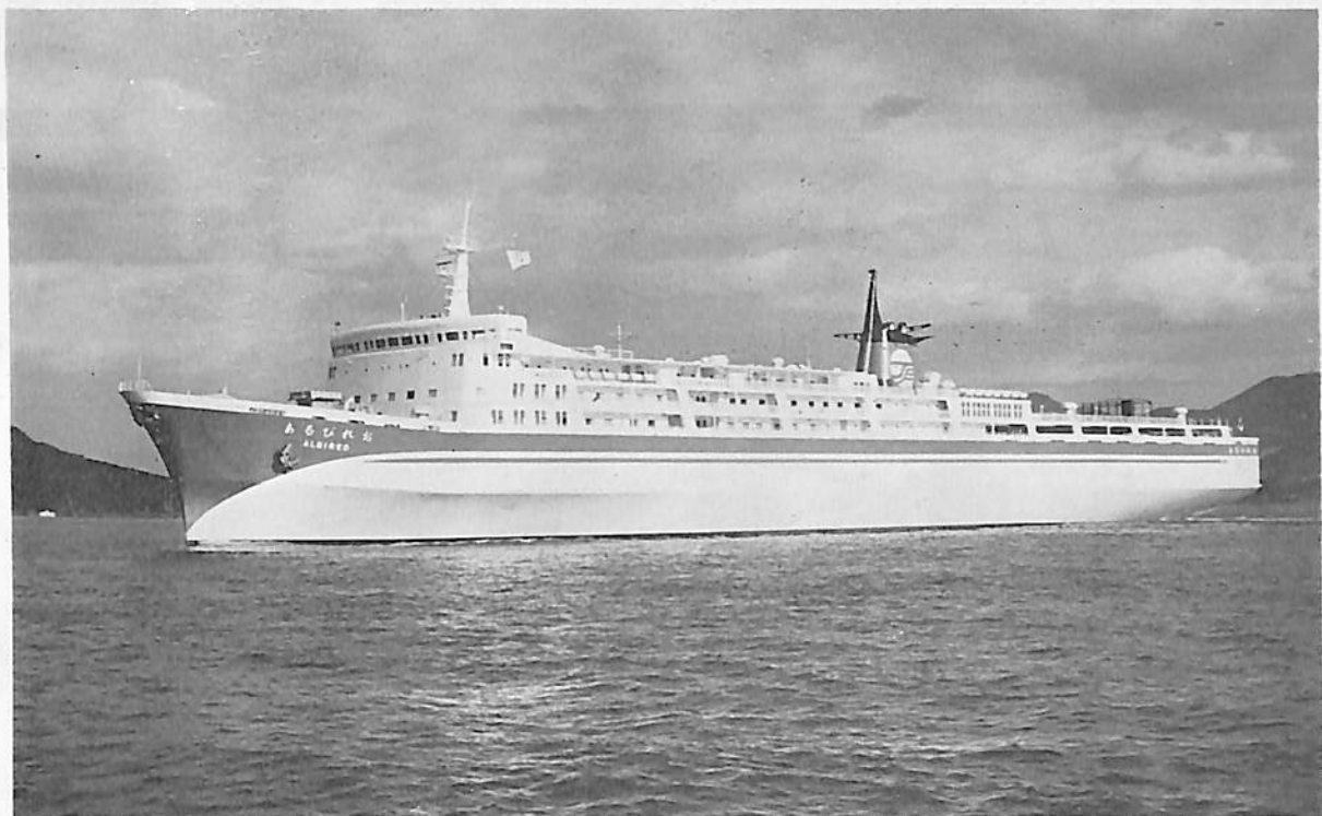
あるひれお(自動車航送客船) 船主 太平洋沿海フェリー株式会社 造船所 内海造船・瀬戸田工場 総噸数 9,749.87噸 純噸数 5,052.47噸 近海 船級 JG 載貨重量 3,330噸 全長 167.22 m 長(垂) 155.00 m 幅(型) 22.00 m 深(型) 9.70 m 吃水 6.45 m 満載排水量 10,640噸 全通船楼二層甲板船 主機 日立 B&W 16 U 45 HU 型ディーゼル機関 2 基 出力 2×8,000PS×171RPM 燃料消費量 63.25 t/d 航続距離 4,975 海里 速力 21.55ノット 諸車搭載台数 車両甲板上 8 トン積トラック 95 台 船楼甲板上 乗用車 75 台 燃料油倉 633.94 m 3 清水倉 1,126.98 m 3 乗員 69 名 工期 46-12-13, 47-9-8, 48-1-10 航路 大分一名古屋一仙台一苫小牧
