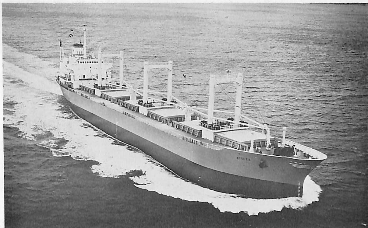
EFTHITIS (貨物船) 船主 Efthitis Compania Financiera S. A. (パナマ) 造船所 石川島播磨重工業・東京工場 総噸数 9,812.97 噸 純噸数 6,231 噸 遠洋 船級 AB 載貨重量 15,187 噸 全長 143.402 m 長(垂) 134.112 m 幅(型) 19.812 m 深(型) 12.344 m 吃水 9.035 m 船尾樓付平甲板型 主機 IHI ビールスチックディーゼル機関 1 基 出力(連続最大) 5,130 PS×500 RPM (常用) 4,540 PS×480 RPM 燃料消費量 18.2 t/d 航続距離 19,000 海里 速力(試) 16.16 ノット (航) 13.6 ノット 貨物倉(ベール) 18,888.7 m 3 (グリーン) 20,140.8 m 3 燃料油倉 1,356.3 m 3 清水倉 174.2 m 3 乗員 30 名 工期 47-5-30, 47-9-28, 48-1-8
