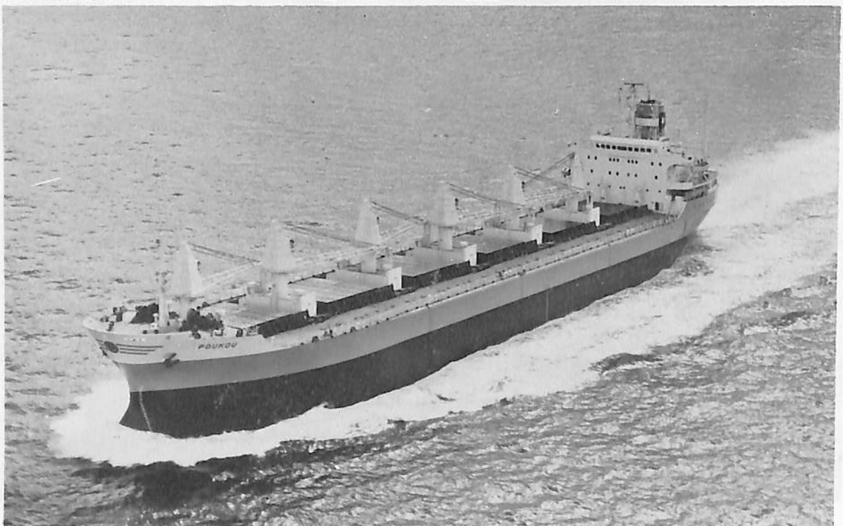
POUKOU (ばら積貨物船) 船主 Pure Bulkcarriers (Corp, リベリア) 造船所 三井造船・藤永田造船所 全長 179.00 m 長(垂) 170.00 m 幅(型) 27.00 m 深(型) 14.80 m 吃水 10.96 m 総噸数 18,891.92 噸 載貨重量 33,796 噸 貨物倉(グリーン) 44,131 m 3 速力(公試) 17.265 ノット (満載) 15.25 ノット 主機 三井 B&W 6 K 74 EF 型ディーゼル機関 1 基 出力(定格) 11,600 PS×124 RPM (常用) 10,600 PS×120 RPM 船級 LR 工期 47-6, 47-8, 48-1-18
