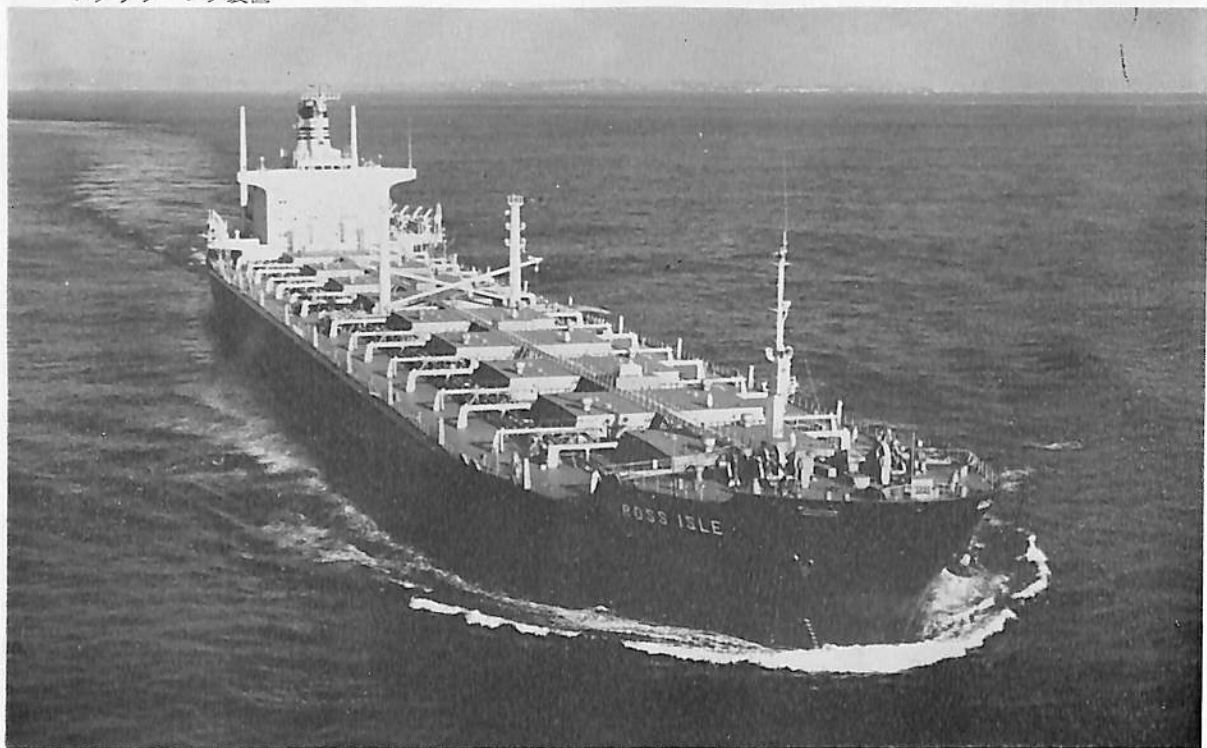
ROSS ISLE (鉸, ばら, 油運搬船) 船主 Rosshavet-Vestfold (ノルウェ) 造船所 日本鋼管・鶴見造船所 総噸数 61,778.94 噸 純噸数 39,799.39 噸 遠洋 船級 NV 載貨重量 111,910 噸 全長 264.320 m 長(垂) 252.000 m 幅(型) 38.000 m 深(型) 22.400 m 吃水 16.484 m 満載排水量 132,426 噸 平甲板型 主機 三井 B&W 9 K 84 EF 型ディーゼル機関1基 出力 21,100 PS×110 RPM 燃料消費量 76.3 t/d 航続距離 21,700 海里 速力 16.2ノット 貨物倉(グリーン) 116,651.4 m 3 燃料油倉 4,499.1 m 3 清水倉 445.2 m 3 乗員 40名 工期 47- 5-12, 47-8-22, 48-1-12 同型船 JARMA, JARMINA
