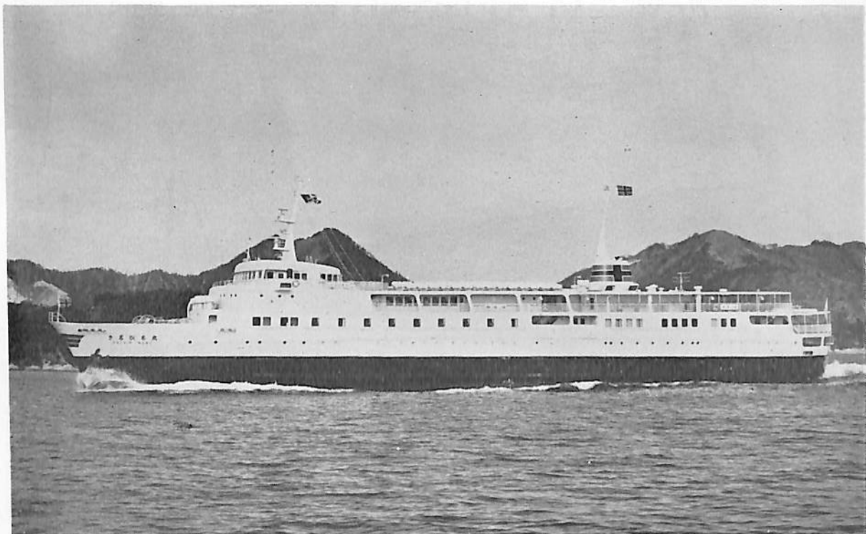
さるひあ丸(旅客船) 船主 船船舶整備公団, 東海汽船株式会社 造船所 内海造船・田熊工場 総噸数 3,079.39噸 純噸数 1,670.27噸 沿海 船級 JG 載貨重量 683.57噸 全長 93.00 m 長(垂) 86.00 m 幅(型) 14.00 m 深(型) 5.90 m 吃水 4.00 m 満載排水量 2,670.00噸 全通船楼甲板船 主機 新潟録工所立型 単動 4 サイクルトランクピストン型排気タービン過給機付ディーゼル機関 1 基 出力 3,060 PS×379/221 RPM 燃料消費量 26.4 t/d 航続距離 2,124 海里 速力 17.70ノット 旅客 最大 2,201 名 燃料油倉 154.38 m 3 清水倉 381.12 m 3 乗員 56 名 工期 47-6-23, 47-9-26, 48-1-13 バウスラスタースター装備, アンチローリン グタンク装備(フリーム式) 航路 東京一大島一三宅島
