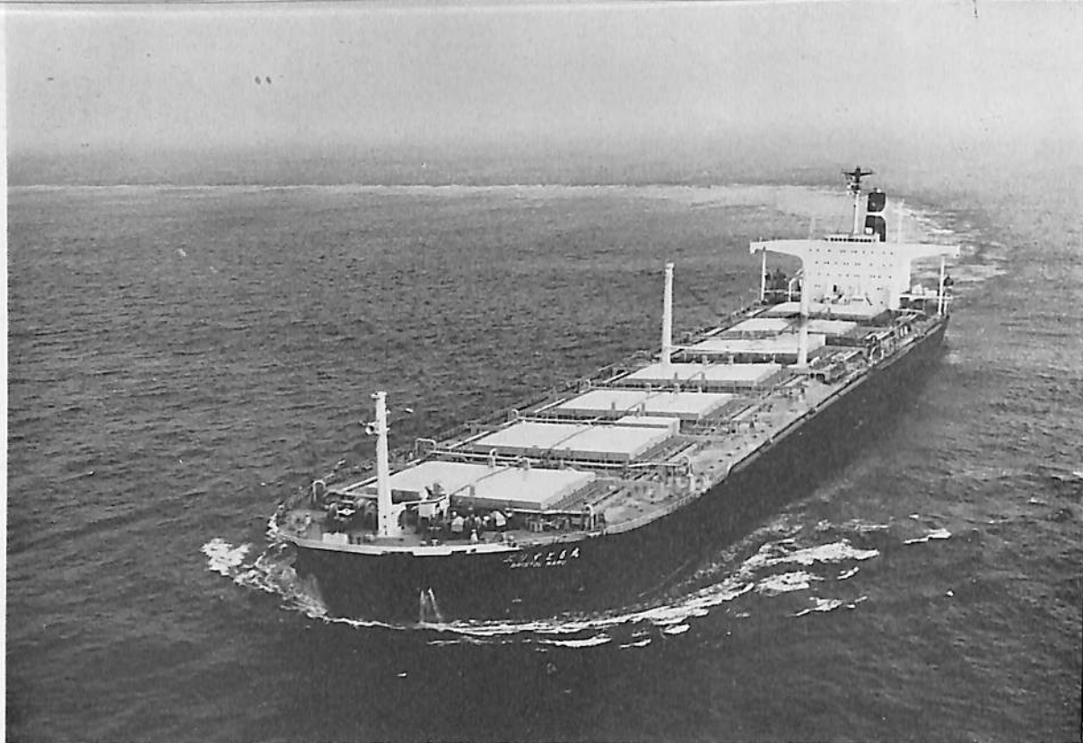
ぶりすとる丸 (鉸, 炭, 油兼用船) 船主 第一中央汽船株式会社 造船所 住友重機械工業・追浜造船所 総噸数 96,010.19 噸 純噸数 74,914.46 噸 遠洋 船級 NK 載貨重量 168,394 噸 全長 297.50 m 長(垂) 285.00 m 幅(型) 47.40 m 深(型) 24.80 m 吃水 17.58 m 満載排水量 20,510 噸 平甲板船 主機 住友スタルラバル APタービン1基 出力 25,800 PS×83 RPM 燃料消費量 127 t/d 航続距離 28,000 海里 速力 15.42ノット 貨 物倉(グリーン) 157,255 m 3 貨油倉 211,374 m 3 燃料油倉 9,676 m 3 清水倉 380 m 3 乗員 38名 工期 47-4 -25, 47-10-11, 48-1-25 同型船 はんぶとん丸, ばしふいっく丸 イナートガスシステム, 固定式タ ンクリリーング装置
