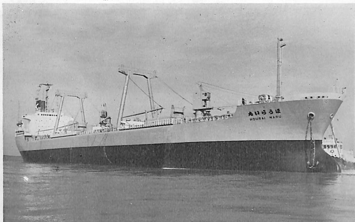
ほうらい丸 (貨物船) 船主 くみあい船舶株式会社 造船所 今治造船株式会社 総噸数 16,203.39 噸 純噸数 9,663.54 噸 遠洋 船級 NK 載貨重量 25,918.1 噸 全長 175.30 m 長(垂) 166.30 m 幅(型) 23.50 m 深(型) 14.50 m 吃水 10.00 m 満載排水量 32,732.0 噸 船首楼付平甲板型 主機 三菱スルザー 6 RND 68 型ディーゼル機関 1 基 出力 8,910 PS×145 RPM 燃料消費量 36 t/d 航続距離 15,410 海里 速力 15.20 ノット 貨物倉(グリーン) 31,758 m 3 燃料油倉 1,715.7 m 3 清水倉 638.6 m 3 乗員 32 名 工期 47-6-4, 47-10-27, 47-12-22
