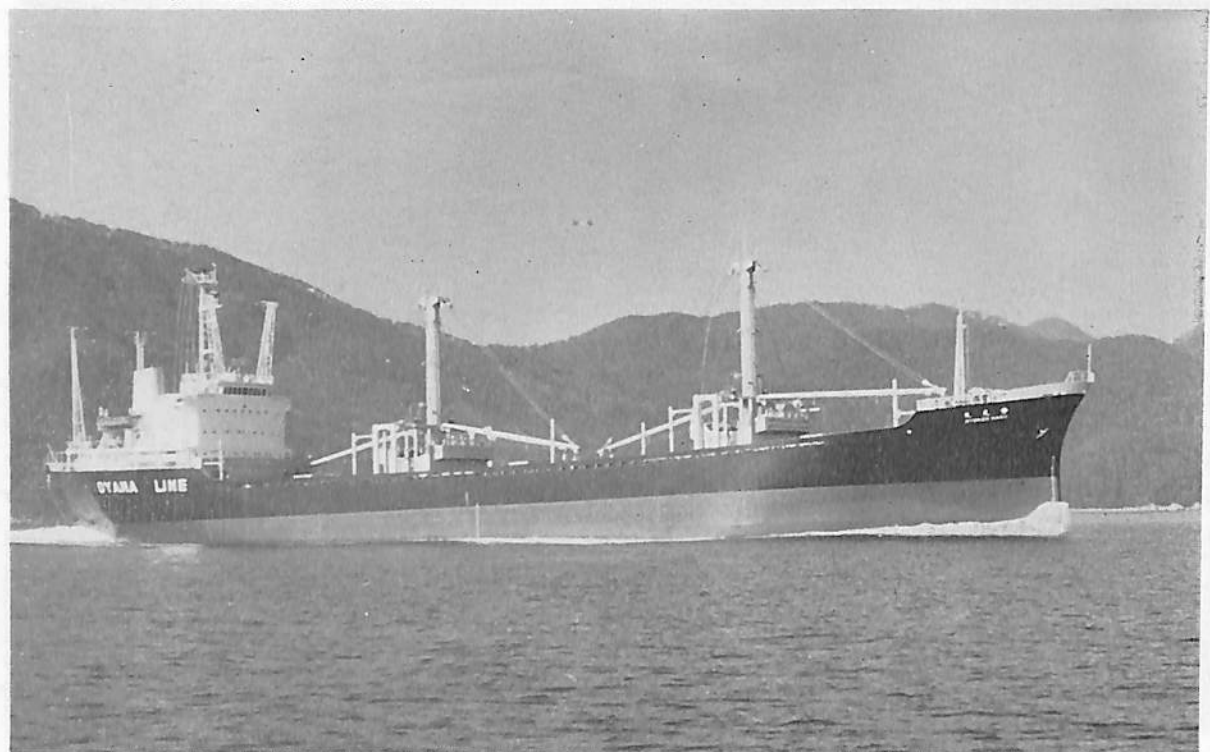
妙 見 丸 (貨物船) 船主 三井物産株式会社, 日豊海運株式会社 造船所 株式会社 宇品造船所 総噸数 6,250.41 噸 純噸数 3,672.43 噸 遠洋 船級 NK 載貨重量 10,491.4 噸 全長 126.83 m 長(垂) 118.00 m 幅(型) 19.20 m 深(型) 9.80 m 吃水 7.769 m 滿載排水量 13,482 噸 凹甲板船 主機 赤阪鉄工所製 6 UET 52/90 D 型ディーゼル機関 1 基 出力 5,100 PS×188 RPM 燃料消費量 18.46 t/d 航続距離 17,500 海里 速力 13.5 ノット 貨物倉(ベール) 12,241.1 m 3 (グレーン) 12,516.4 m 3 燃料油倉 1,279.76 m 3 清水倉 740.57 m 3 乗員 30 名 工期 47-8-10, 47-11-7, 47-12-25
