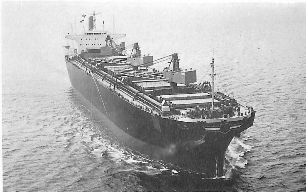
豪 陽 (GOHYO) (チップ運搬船) 船主 Tasmanian Transportation Incorporated (リベリア) 造船所 住友重機械工業・浦賀造船所 長(垂) 188.00 m 幅(型) 29.40 m 深(型) 20.80 m 吃水 10.80 m 総噸数 31,860.86 噸 載貨重量 37,190 噸 速力(試) 17.08 ノット 主機 住友スルザー 6 RND 76 型ディー ゼル機関 1 基 出力 12,000 PS×122 RPM 船級 BV 工期 47-7-24, 47-11-2, 47-2-7 設備 チップアンローダ, 旋回式俯仰型固定クレーン 600 kt/h×3
