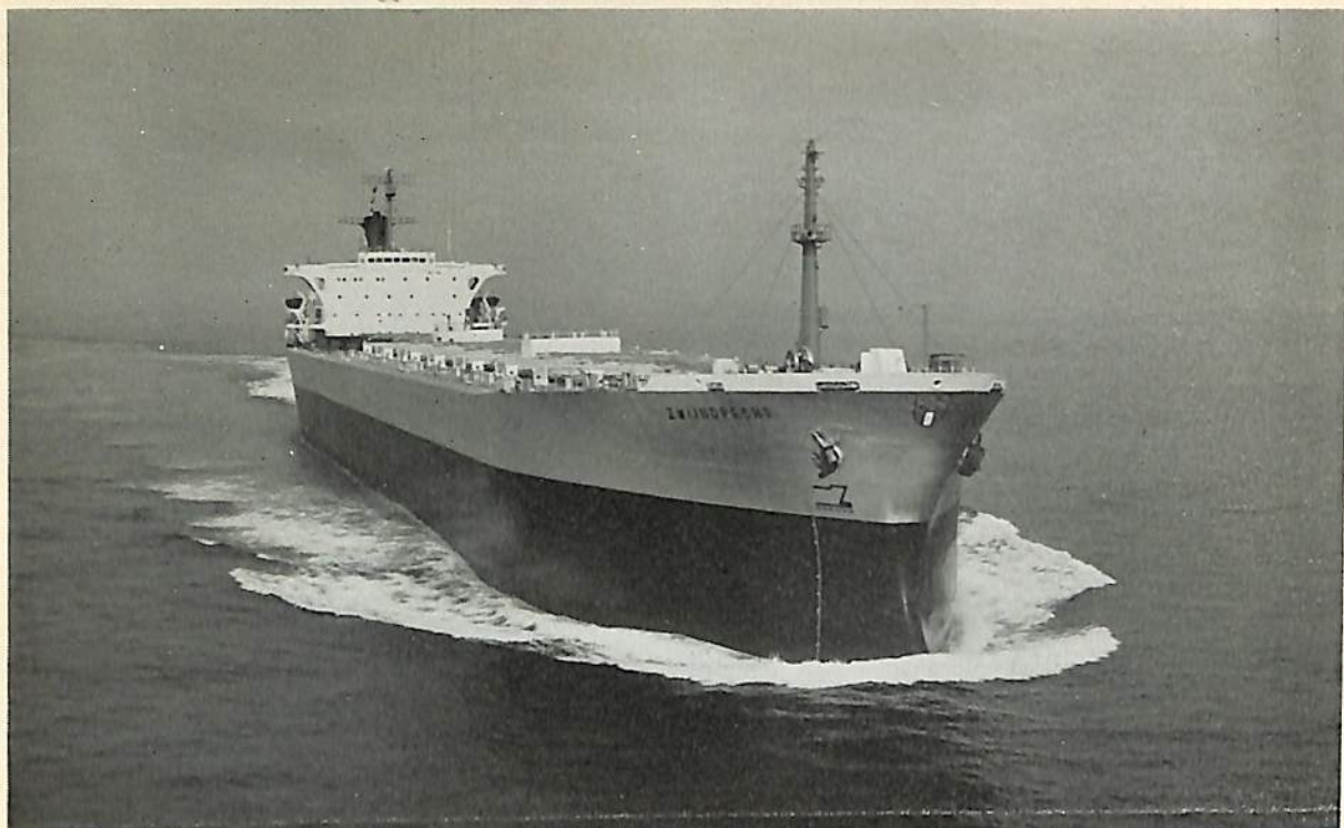
ZWIJNDRECHT (ばら積貨物船) 船主 Shipping Company Zwijndrecht NV.(オランダ) 造船所 日本鋼管・鶴見造船所 総噸数 38,611.27 噸 純噸数 31,185.26 噸 遠洋 船級 AB 載貨重量 67,826 噸 全長 224.00 m 長(垂) 214.00 m 幅(型) 32.20 m 深(型) 18.70 m 吃水 13.603 m 満載排水量 79,935 噸 平甲板船 主機 住友スルザー 6 RD 90 型ディーゼル機関 1 基 出力 12,750 PS×116 RPM 燃料消費量 47.4 t/d 航続距離 18,100 海里 速力 14.7 ノット 発電機 470 KW×3 貨物倉(グリーン) 81,318.2 m 3 燃料油倉 2,931 m 3 清水倉 413 m 3 乗員 52 名 工期 47-7-3, 47-10-24, 48-2-10
