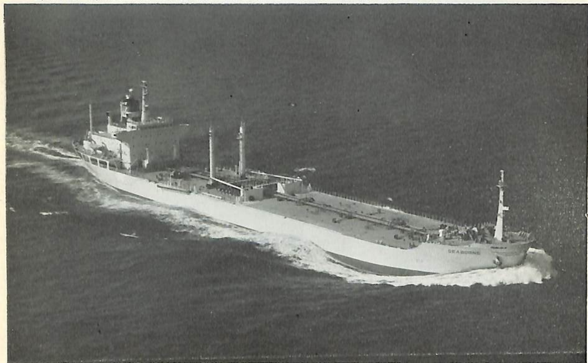
SEABORNE (油槽船) 船主 Seaborne Tankers Inc.(リベリア) 造船所 株式会社 名村造船所 総噸数 15,027.38 噸 純噸数 9,933 噸 遠洋 船級 AB 載貨重量 30,169 噸 全長 171.02 m 長(垂) 162.00 m 幅(型) 25.40 m 深(型) 14.35 m 吃水 10.713 m 満載排水量 37,082 噸 凹甲板船 主機 三菱スルザー 7 RN D 68 型ディーゼル機関 1 基 出力 9,820 PS×142 RPM 燃料消費量 38.0 t/d 航続距離 16,500 海里 速力 15.0 ノット 発電機 AC700 KVA(560 W)×450 V×2 貨油倉 34,050 m 3 燃料油倉 2,019.2 m 3 清水倉 254.8 m 3 乗員 40 名 工期 47-8-26, 47-11-7, 48-2-9
