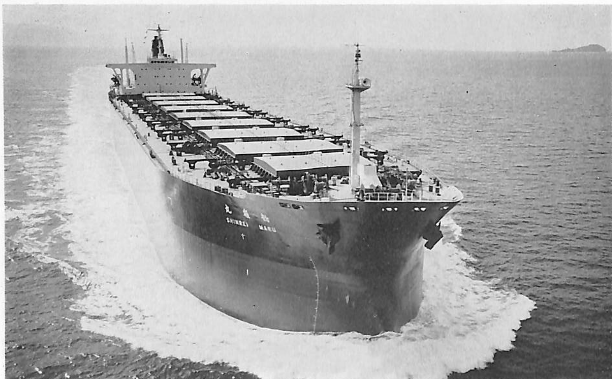
新 嶺 丸 (ばら積貨物船) 船主 新和海運株式会社 造船所 三菱重工業・広島造船所 総噸数 68,193.52 噸 純噸数 45,080.14 噸 遠洋 船級 NK 載貨重量 122,648 噸 全長 261.00 m 長(垂) 247.00 m 幅(型) 40.60 m 深(型) 24.00 m 吃水 16.831 m 満載排水量 143,482 噸 平甲板船 主機 三菱ス ルザー 9RND90 型ディーゼル機関 1 基 出力 22,185 PS×116 RPM 燃料消費量 81.4 t/d 航続距離 28,800 海 里 速力 15.30 ノット 発電機 AC 450 V 60 Hz 937.5 KVA×3 貨物倉(グレーン) 140,217.5 m 3 燃料油倉 7,302.4 m 3 清水倉 592.5 m 3 乗員 32 名(外 2 名) 工期 47-7-28, 47-11-8, 48-2-9
