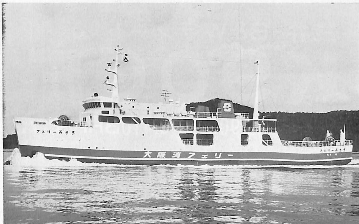
フェリー みさき (自動車航送旅客船) 船主 大阪湾航送船株式会社 造船所 内海造船・田熊工場 総噸数 804.12 噸 純噸数 289.13 噸 近海 船級 JG 載貨重量 384.66 噸 全長 57.438 m 長(垂) 53.000 m 幅(型) 12.900 m 深(型) 4.100 m 吃水 3.260 m 満載排水量 1,255 噸 平甲板船 主機 ダイハツ 8 DSM-26 型 ディーゼル機関 2 基 出力 2 \times 1,360 PS \times 682/340 RPM 燃料消費量 11.5 t/d 航続距離 1,635 海里 速力 14.6 ノット 燃料油倉 61.64 m 3 清水倉 37.04 m 3 旅客定員 500 名, 乗用車 5 台搭載可能, 8t 積トラック 13 台 乗員 18 名 工期 47-8-3, 47-11-21, 48-2-23 設備 レーダー, ジャイロコンパス, 吃水計, ハウス ラスター, トリムヒール制御装置, 汚水処理装置
