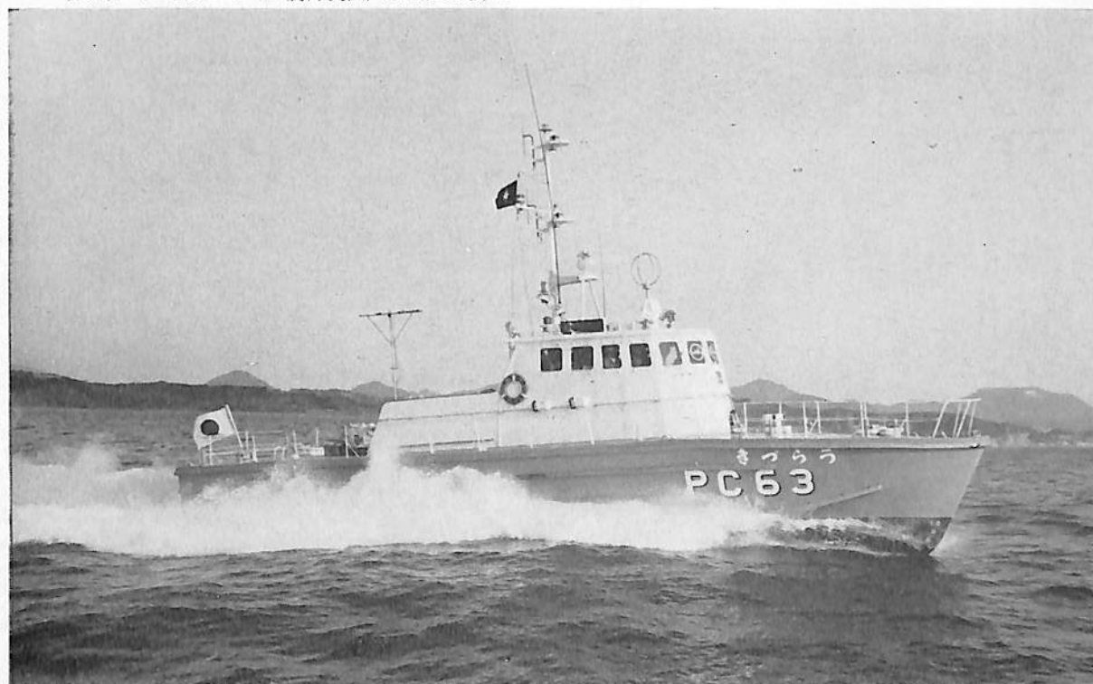
うらづき (23m型巡視艇) 船主 海上保安庁 造船所 三菱重工業・下関造船所 総噸数 67.17 噸 純噸数 17.30 噸 沿海 4 種船 全長 21.00 m 長(垂) 20.00 m 幅(型) 5.20 m 深(型) 2.70 m 吃水 1.23 m 満載排水量 45.96 排水トン 船型 V 型 主機 池貝ベント MB 820 Db 型ディーゼル機 関 2 基 出力(最大) 1,100 PS \times 1,400 RPM 航続距離 230 海里 速力(試) 26.32 ノット (航) 25 ノット 乗員 10 名 同型船 はるづき, きよづき 第 6 管区広島海上保安部配属
