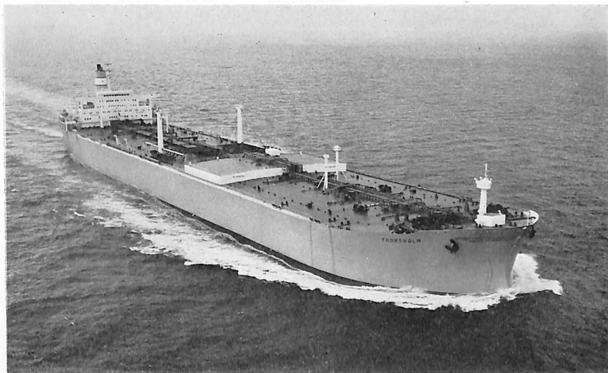
THORSHOLM (油槽船) 船主 A/S Thor Dahl (ノルウェー) 造船所 三井造船・千葉造船所 総噸数 139,680.18 噸 純噸数 106,643.58 噸 遠洋 船級 LR 載貨重量 279,810 Lt 全長 342.900 m 長(垂) 329.184 m 幅(型) 51.816 m 深(型) 27.737 m 吃水 21.773 m 満載排水量 320,334 噸 平甲板型 主機 三井 B&W 9 K 98 FF 型ディーゼル機関 1 基 出力 31,500 PS×100 RPM 燃料消費量 142.6 gr/ihp/hr 速力 14.70 ノット 貨油倉 342,073.1 m 3 燃料油倉 9,403.7 m 3 清水倉 835.1 m 3 乗員 41 名 工期 47-5-18, 47-10-24, 48-2-15 設設 固定タンククリーニング装置, イナートガス装置, ドライパウダー消火装置, ノルコン-コンピュータコントロールシステム
