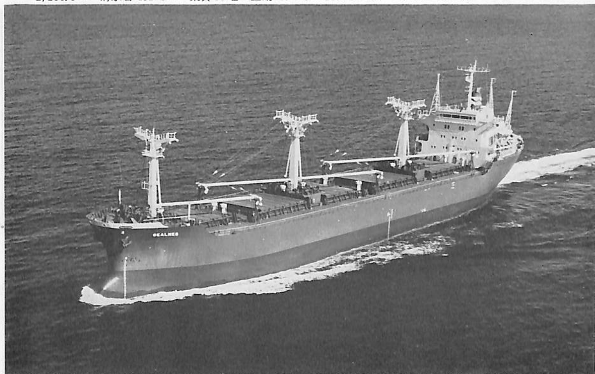
SEALNES (ばら積貨物船) 船主 The Bishopsgate Shipping Company Ltd (英) 造船所 日本鋼管・清水造船所 総噸数 12,982.17 噸 純噸数 8,040.47 噸 遠洋 船級 LR 載貨重量 21,570 噸 全長 155.517 m 長(垂) 145.70 m 幅(型) 22.86 m 深(型) 13.40 m 吃水 9.839 m 満載排水量 26,263 噸 凹甲板船 主機 NKK-ピールステック 18PC 2-2 V 400 型ディーゼル機関 1 基 出力 8,100/7,970 PS×500/126 RPM 燃料消費量 32 t/d 航続距離 13,100 海里 速力 14.8 ノット 汽罐 コンボジット罐×1 発電機 AC 437.5V 350 KW×3 貨物倉(ベール) 25,852.1 m 3 (グレーン) 26,892.1 m 3 燃料油倉 1,258.3 m 3 清水倉 140.4 m 3 乗員 32 名 工期 47-8-23, 47-11-24, 48-2-24 同型船 SWIFTNES, SALTNES, SPRAYNES
