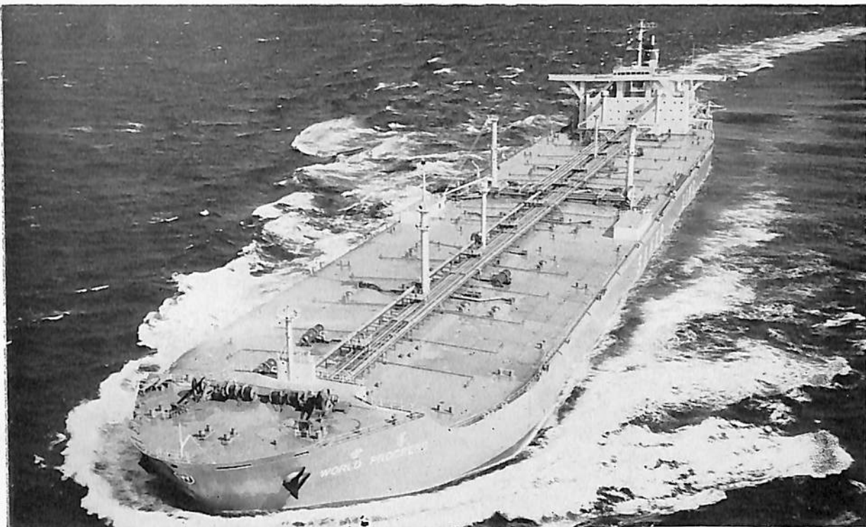
WORLD PROGRESS (世尊) (油槽船) 船主 Liberian Begonia Transports Inc. (リベリア) 造船所 三菱重工業・長崎造船所 総噸数 105,787.23 噸 純噸数 87,238.94 噸 遠洋 船級 BV, NK 載貨重量 237,285 噸 全長 321.82 m 長(垂) 304.00 m 幅(型) 52.40 m 深(型) 25.70 m 吃水 19.886 m 船首楼付平甲板船 主機 三菱 2 段減速装置付タービン 1 基 出力 34,000 PS×90 RPM 燃料消費量 166.5 t/d 航続距離 17,000 海里 速力 15.8 ノット 汽罐 三菱 CE 貨油倉 289,153.9 m 3 燃料油倉 8,271.1 m 3 清水倉 760.1 m 3 乗員 50 名 工期 47-5-23, 47-11-28, 48-2-20 同型船 新光丸
