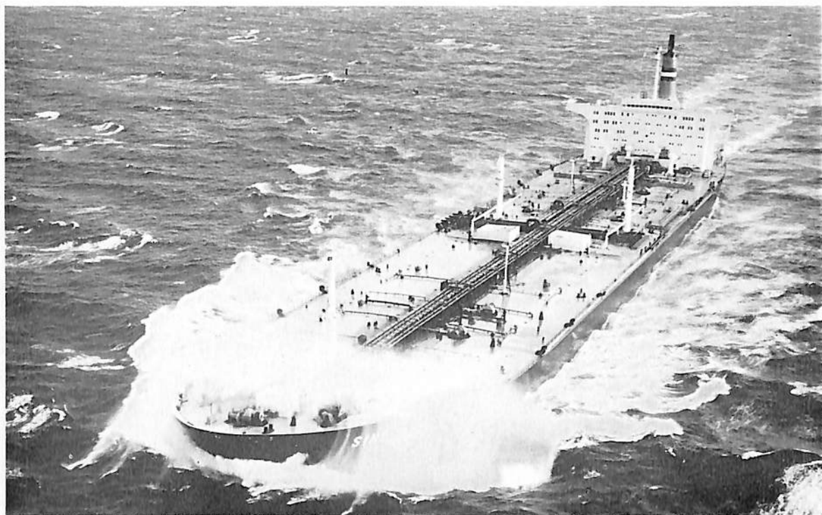
SINDE (油槽船) 船主 Sequoia Tanker Corporation Ltd. (パナマ) 石川島播磨重工業・呉工場 総噸数 125,421.88噸 純噸数 102,950噸 遠洋 船級 AB 載貨重量 271,686Lt 全長 337,058m 長(垂) 320.00m 幅(型) 54.50m 深(型) 27.00m 吃水 69'- \frac{3}{4} " 平甲板船 主機 IHI 船用タービン×1 出力 33,000PS ×80RPM 燃料消費量 160.9t/d 航続距離 26,663海里 速力 16.02ノット 貨油倉 331,926.9m 3 清水倉 649.4m 3 燃料油倉 13,432.5m 3 乗員 54名, 外3名, 計 57名 工期 47-8-19, 47-11-15, 48-3-8
