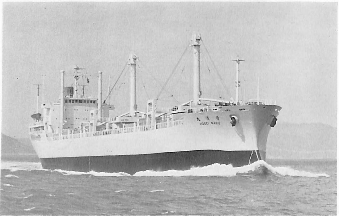
普 清 丸 (貨物船) 船主 Marbo Enterprises Limited (ホンコン) 造船所 幸陽船渠株式会社 総噸数 15,624.68噸 純噸数 11,021.95噸 遠洋 船級 NK 載貨重量 25,871.66噸 全長 175.850m 長(垂)164.900 m 幅(型)22.480m 深(型)14.600m 吃水 10.5025m 満載排水量 33,513.50噸 主機 IHI-スルザー 7RND68 2 サ イクルディーゼル機関 1 基 出力 10,395PS×144.8RPM 燃料消費量 39.600t/d 航続距離 11,000海里 速力 15.0ノット 汽罐 立型自然循環水管式 7~5kg/cm 2 発電機 575KVA×2 貨物倉(ペール)30,462.31m 3 (グリーン) 32,565.51m 3 清水倉 605.920m 3 燃料油倉 1,665.01m 3 乗員 34名 工期 47-9-6, 47-11-9, 48-3-15
