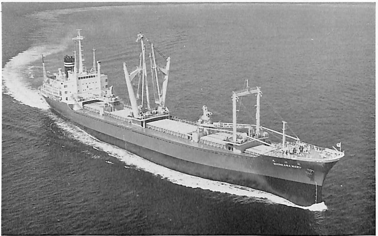
新川丸 (定期貨物船) 船主 新田汽船株式会社 造船所 林兼造船株式会社・長崎造船所 総噸数 9,617.47噸 純噸数 6,402.10噸 遠洋 船級 NK 載貨重量 13,601.31噸 全長155.60m長(垂)147.11 m 幅(型)21.20m 深(型) 12.20m 吃水 9.413m 満載排水量 19,081.50噸 凹甲板型 主機 川崎MAN K6Z70/ 120E型 ディーゼル機関1基 出力 8,370PS×135RPM 燃料消費量157.2g/ps/h 航統距離 13,700海里 速力 16.80ノット 発電機 720KVA×720RPM 2台 貨物倉(ベール) 18,762.18m 3 (グリーン)20,480.52 m 3 清水倉 714.81m 3 燃料油倉 A 190.59m 3 C 1,349.36m 3 乗員 38名 工期47-9-26, 47-12-21, 43-3-20 設備 85t ヘビーブーム 1(シュッルケン), デッキクレーン(10t×2) 一部冷凍貨物倉あり
