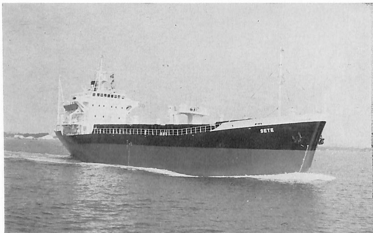
SETE (ばら積貨物船) 船主 Societe Maritime Nationale (フランス) 造船所 東北造船株式会社 総噸数 3,204.11噸 純噸数 1,913.11噸 遠洋 船級BV 載貨重量 5,640.31噸 全長 85.818m 長(垂) 79.228m 幅(型)15.240m 深(型) 9.144噸 吃水 7.448m 満載排水量 6,957.14噸 平甲板船尾機関型 主機 阪神内燃機6LU 38型 出力 1,700PS×294 RPM 燃料消費量 7.65t/d 航続距離 8,000 海里 速力 11.5ノット 発電機 162.5KVA ×2 貨物倉(グリーン) 6,400.9m 3 清水倉 98.2m 3 燃料油倉 270.11m 3 乗組 17名 工期 47-11-9, 48-2- 2, 48-3-31
