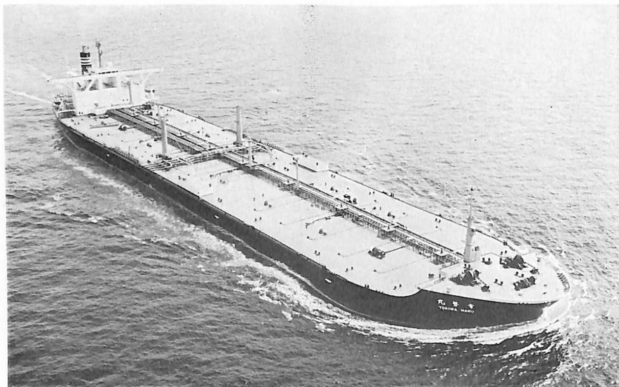
常 盤 丸 (油槽船) 船主 日本郵船(株), 岡田商船(株) 造船所 三菱重工業・長崎造船所 総噸数 116,140.99噸 純噸数 90,327.78噸 遠洋 船級 NK 載貨重量 237,458噸 全長 321.82m長(垂)304.00m 幅(型) 52.40m 深(型) 25.70m 吃水 19,350mm 船首楼付平甲板船 主機 三菱船用タービン×1 出力 34,000PS ×90RPM 燃料消費量 166.5t/d 航続距離 16,000海里 速力 15.8ノット 汽罐 三菱CEV2M-8W型×2 発電機 1,400KW AC450V×1 貨油倉 289,267.3m³ 清水倉 760.1m³ 燃料油倉 8,192.3m³ 乗員 33名 工期 47-7-21, 47-12-15, 48-3-30
