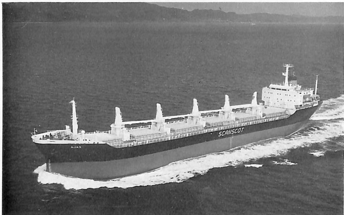
AJAX (ばら積貨物船) 船主 Elder Dempster Lines Ltd. (イギリス) 造船所 三井造船・藤永田造船所 総噸数 16,405噸 船級 AB 載貨重量 26,716噸 全長 176.75m 長(垂) 168.00m 幅(型) 22.86m 深(型) 14.10m 吃水 10.566m 主機 三井B&W 6K74EF型 速力 15.25ノット 出力 10,600PS×120RPM 貨物倉(グリーン) 36,224m 3 乗員 39名 工期 47-10, 48-1, 48-3-28 設備 8噸デッキクレーン×5, 6倉口にはマックグ レーゴ式鋼製倉口蓋装備
