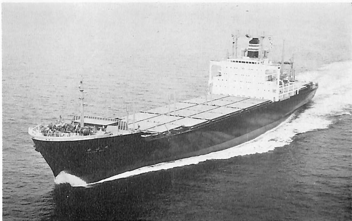
白山丸 (コンテナ船) 船主 日本郵船(株), 昭和海運(株) 造船所 三菱重工業・神戸造船所 総噸数 23,609.21噸 純噸数 12,720.36噸 遠洋 船級 NK 載貨重量 22,965噸 全長 201.00m 長(垂) 195.00m 幅(型) 20.00m 深(型) 16.70m 吃水 10.62m 満載排水量 36,172噸 長船首楼付平甲板船 主機 三菱スルザー 9R ND 105型 ディーゼル機関 1基 出力 30,600PS×102RPM 燃料消費量 150 t/d 航続距離 16,000海里 速 力 22.4ノット 汽罐 3,950kg/h×1 発電機 963KVA×AC450V×4 コンテナ 20'換算にて 1,193箇 貨油倉 967.0m 3 清水倉 1,123.9m 3 燃料油倉 4,668.8m 3 乗員 41名 工期 47-10-12, 47-11-16, 48-3-24
