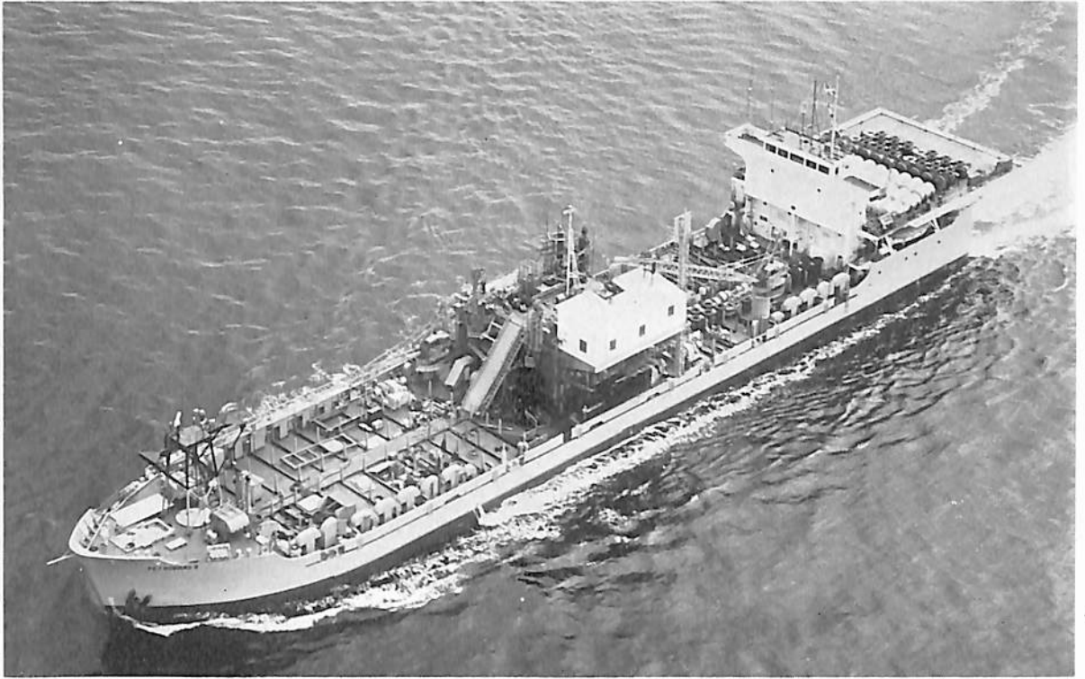
PETROBRAS II (自航式石油掘削船) 船主 Petroles Brasileiro S.A (ブラジル) 造船所 三井造船・玉野造船所 総噸数 5,716.22噸 船級 AB 載貨重量 6,314噸 全長 115,983m 長(垂) 110.434m 幅(型) 21.336m 深(型) 7.925m 吃 水 5.747m 主機 電動モーター 2,000 PS×1,000 RPM×2 (ディーゼル発電機 2,200 PS×1,000 RPM×3) 乗員 37名 (航海時 37名 (作業時 75名) 工期 47-7, 47-12, 48-3-27
