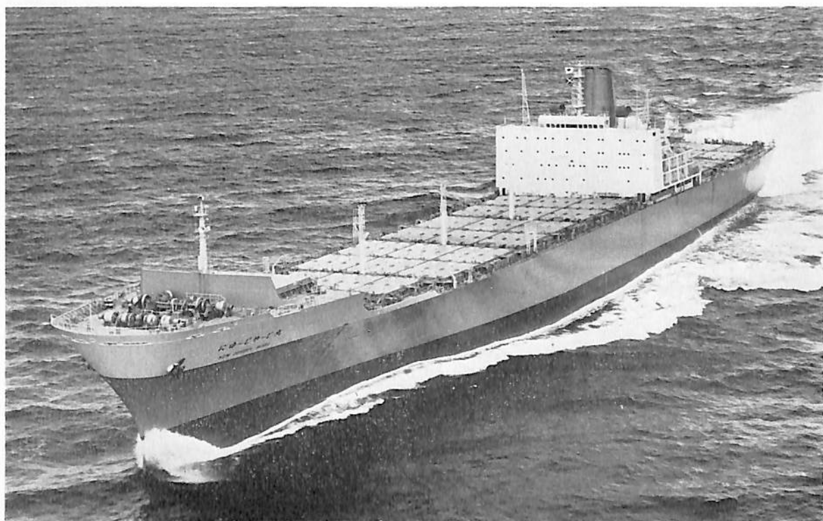
やちじゅう丸 (コンテナ船) 船主 大阪商船三井船舶(株) 造船所 三井造船・玉野造船所 総噸数 37,799.99噸 船級 NK 載貨重量 33,025噸 全長 263.267m 長(垂) 247.06m 幅(型) 32.20m 深(型) 19.80m 吃水 11.529m 主機 三井B&W12K 84EF型(2基2軸) ディーゼル機関 1基 出力 69,600PS×119RPM コンテナ搭載 20'換算 1,887箇 乗員 35名 工期 47-5, 47-11, 48-3-12
