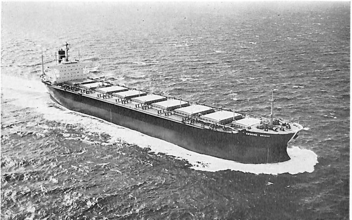
ERSKINE BRIDGE (ばら積貨物船) 船主 H. Olarkson and Co., Ltd. (英) 造船所 三菱重工業・広島造船所 総噸数 65,886.92噸 遠洋 船級 LR 載貨重量 120,144噸 全長 260.78噸 長(垂) 247.00m 幅(型) 40.60m 深(型) 22.50m 吃水 16.532m 満載排水量 40,460噸 船首楼付平甲板船 主機 三菱スルザー-9 RND 90型 出力 22,500PS×116RPM 燃料消費量 81.5 航続距離 約26,500海里 速力 15.7ノット 発電機 AC 450V, 60Hz, 962.5KVA×3 貨物倉 131,478.3m 3 清水倉 349.3m 3 燃料油倉 6,948.1 乗員 41名(外3) 工期 47-9-19 47-12-23, 48-3-23 同型船 STIRLING BRIDGE
