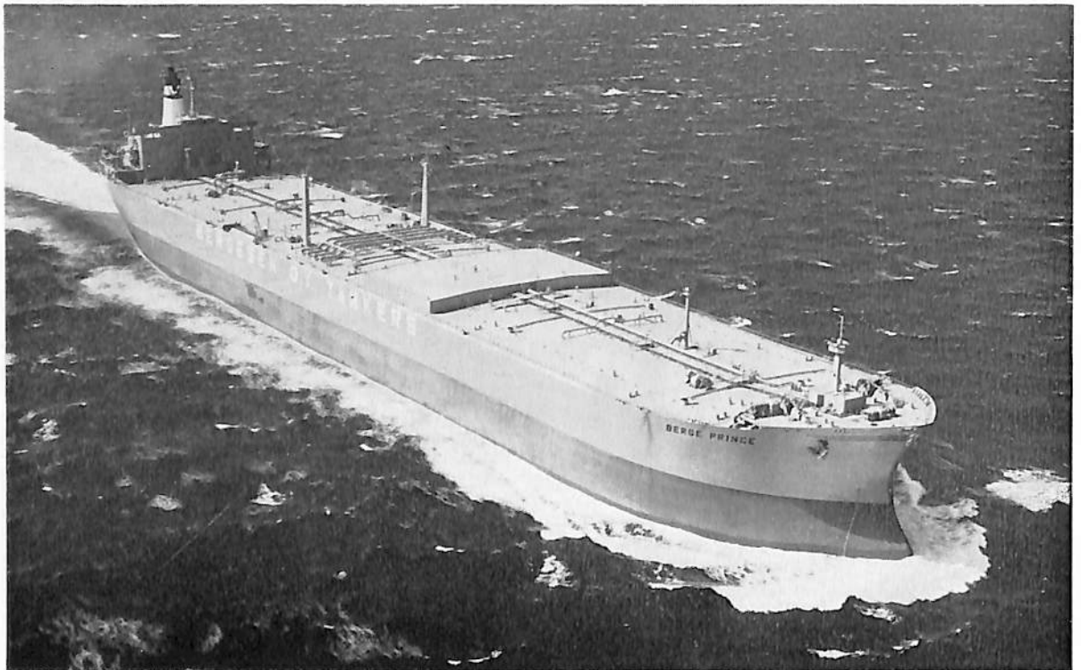
BERGE PRINCE (油槽船) 船主 Sig Bergesen d.y & Co.(ノルウェー) 造船所 三井造船・千葉造船所 総噸数 139,775.62噸 遠洋 船級 LR 載貨重量 280,028噸 全長 342.90m長(垂) 329.184m幅(型) 51.816m深 (型) 27.737m 吃水 21.773m 主機 三井B&W 9 K98FF型 ディーゼル機関1基 出力35,300PS×106RPM 乗員 44名 工期 47-7, 47-12, 48-3-29 設備 ロイドUMS取得船, イナートガス装置
