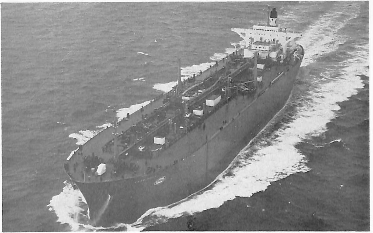
ESSO FUJI (LPG運搬船) 船主 Esso Transport Company Inc (パナマ) 造船所 日立造船・因島工場 総噸数 55,896.84噸 純噸数 40,662.55噸 遠洋 船級 NK 載貨重量 63,396噸 全長 246.128m 長(垂) 234.00m (型) 39.90m 深(型) 25.00m 吃水 12.70m 満載排水量 91,737噸 一層甲板船 主機 日立B&W8K84EF型 ディーゼル機関1基 出力 18,200PS×110RPM 燃料消費量 68.6 t/d 航続距離 22,500 海里 速力 15.4ノット 汽罐 16kg/cm 2 ×20,000kg/h×1 発電機 1,100KVA×AC450V×60Hz 貨物倉 20°Cにて104,213,743m 3 清水倉444.26 m 3 燃料油倉 4,117.15m 3 乗員 42名 工期 47-3-21, 47-8-2, 48-2-2
