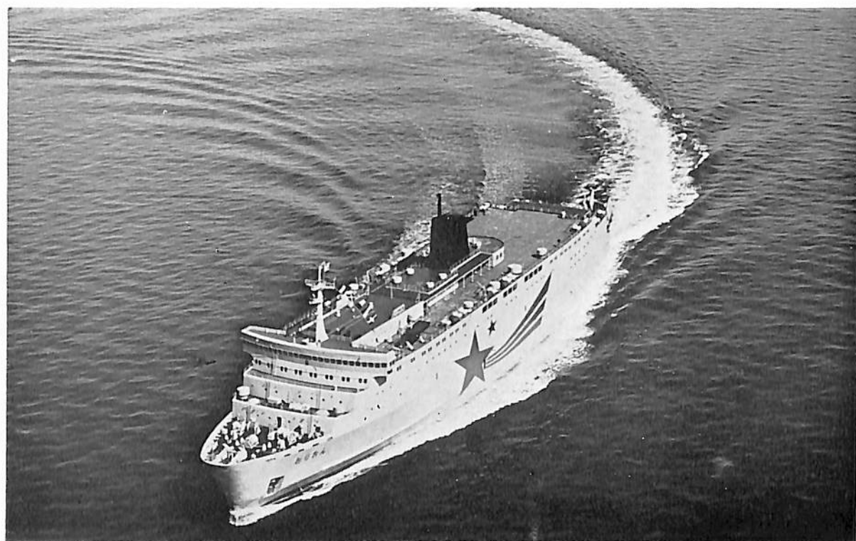
おりおん(自動車航送客船) 船主 大洋フェリー株式会社 造船所 林兼造船・下関造船所 総噸数 7,173.88噸 純噸数 2,758.51噸 近海 載貨重量 2,923.12噸 全長 140.85m 長(垂) 128.00m 幅(型) 22.40m 深(型) 8.00m 吃水 5.819m 満水排水量 8,980.33噸 全通船楼型 主機 三菱 MAN-V-V9V-40/54型ディーゼル機関2基 出力 2×8,500PS×406.7/199RPM 燃料消費量 66t/d 航続距離 3,200海里 速力 21.50ノット 汽罐 クレイトン式2基 発電機 712.5KVA×4 清水倉 342.20m 3 燃料油倉 510.90m 3 船客 594名 ドライバー 48名 車両トトラック 94台 乗用車 72台 乗員 56名 工期 47-3-31, 47-8-10, 48-2-28
