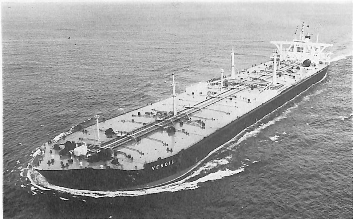
VENOIL (油槽船) 船主 Venoil Inc. (リベリア) 造船所 三菱重工業・長崎造船所 総噸数 152,327.08噸 純噸数 130,729噸 遠洋 船級 AB 載貨重量 325,728噸 全長 340.00m長(垂)322.00m幅 (型)53.60m 深(型) 32.00m 吃水 80'-11½"m 平甲板型 主機 三菱2段減速機付船舶用タービン1基 出力 36,000PS×90RPM 燃料消費量 174t/d 航続距離 30,000海里 速力 15.0ノット 汽罐 三菱C.E-V2M-8W ×2 発電機 1,400KW×AC450V×1 貨油倉 396,028.8m³ 清水倉 474.8m³ 燃料油倉 16,750.7m³ 乗員 52名 工期 47-6-26, 47-10-2, 48-3-15
