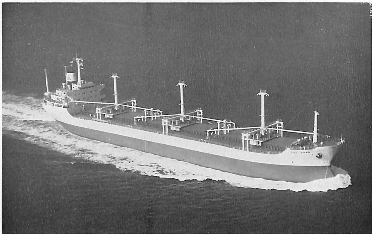
JILL CORD (ばら積貨物船) 船主 Concord Line A/S (デンマーク) 造船所 三井造船・藤永田造船所 総噸数 19,576.36噸 船級LR 載貨重量 33,915噸 全長 179.00m 長(垂)170.00m 幅(型)27.00m 深(型)14.80m 吃水 10.96m 主機 三井B&W 6 K74EF 型×1 出力 10,600PS×120RPM 貨物倉(グリーン) 44,131m 3 工期 47-10, 47-12, 48-3-23
