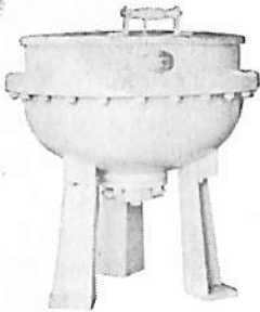
ライスボイラー
