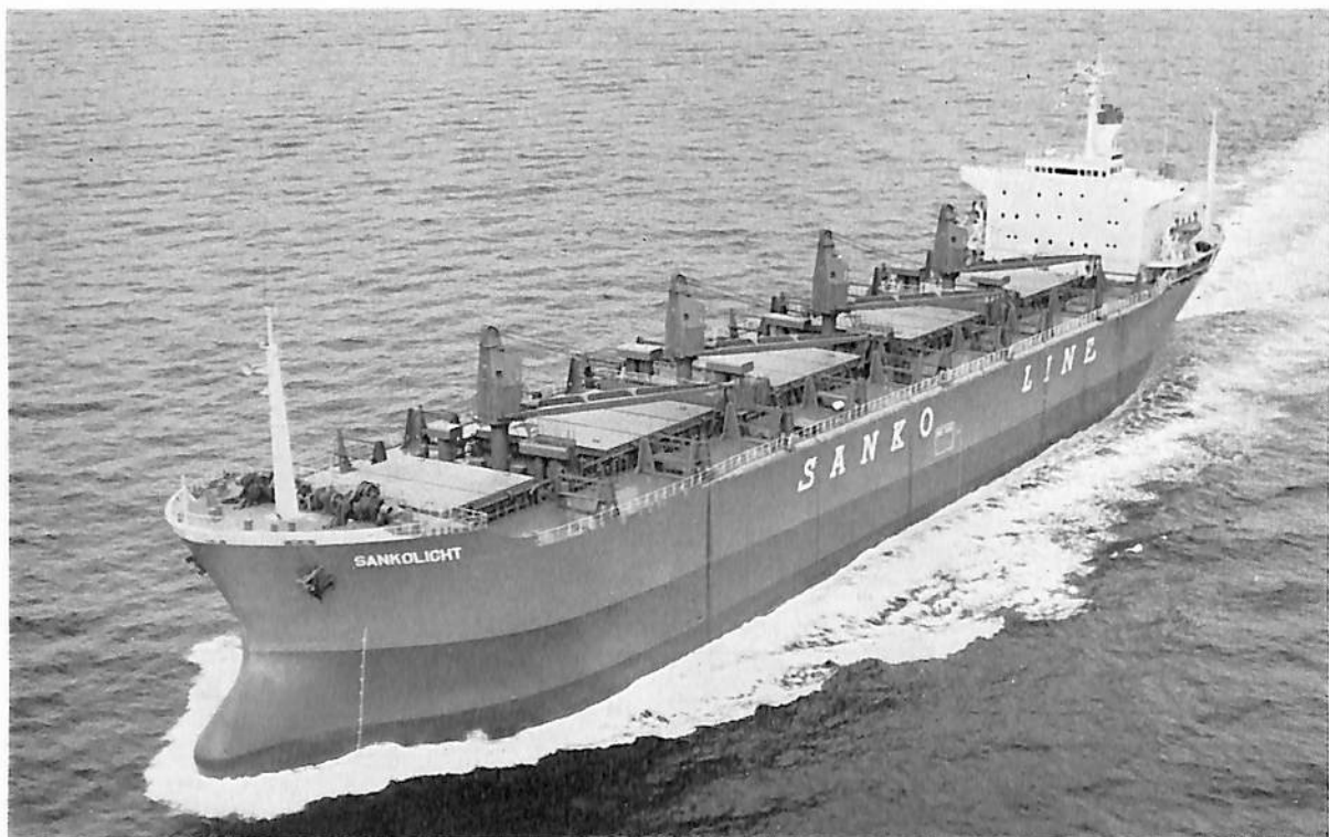
SANKOLIGHT (自動車兼ばら積貨物船) 船主 Anca Shipping Inc. (リベリア) 造船所 佐野安船渠株式会社 総噸数 20,713.49噸 遠洋 船級 BV 載貨重量 37,445 Lt 全長 180.64m 長(垂)170.00m 幅(型)27.60m 深(型) 17.00m 吃水 12.00m 船型 凹甲板型 主機 IHI-スルザー 7RND76型ディーゼル機関1基 出力 14,000 PS×122RPM 航続距離 17,500海里 速力 15.1ノット 汽罐 15,500kg/h×7kg/cm 2 G×1 発電機 550KVA×AC450V×3 貨物倉(ベール)41,012m 3 (グリーン)42,255m 3 乗員 39名 工期 47-10-11, 48-1-12 48-3-23 自動車搭載(ブルーバード級) 2,172台
