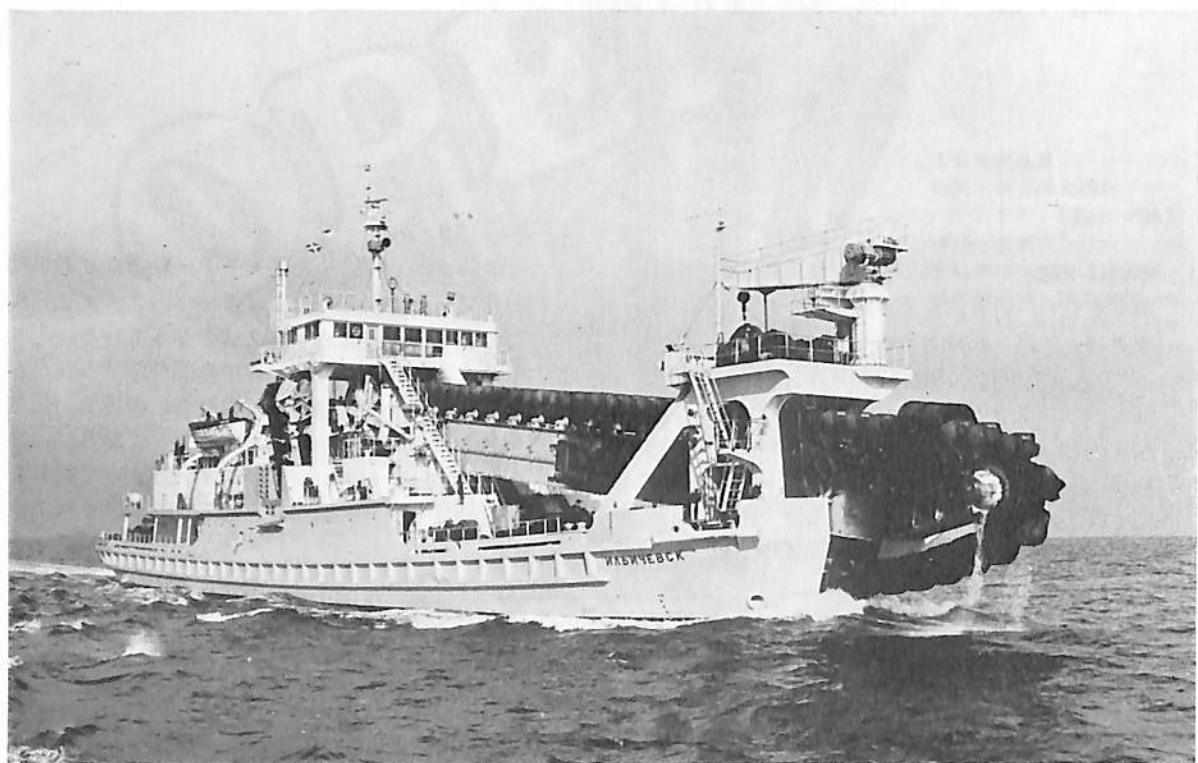
SLICHEVSK (浚渫船) 船主 Sudoimport Ussr 造船所 日本鋼管株式会社鶴見造船所 総噸数 1,701.56噸 純噸数 502.57噸 船級 U.S.S.R. CATEGORY II 載貨重量 335.9噸 全長 74.100m 長(垂) 69.900m 幅(型) 14.000m 深(型) 5.100m 吃水 3.113m 満載排水量 2222.9噸 船首ウェル型 推進用電 動機 立型単動4サイクル過給機付ディーゼル機関 出力 1,700 PS×500RPM 燃料消費量 184.2kg/h 航続距 離 6,200海里 速力 7.8ノット 貨物倉(ペール) 473m 3 清水倉 92m 3 燃料油倉 168m 3 乗員 30名 工期 72-6 -6, 72-10-19-, 73-3-31
