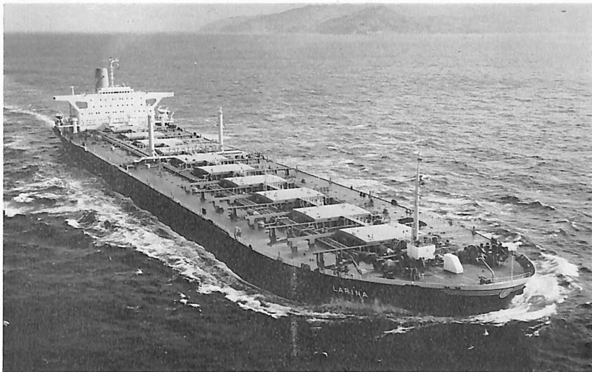
LARINA (鉍石兼油槽船) 船主 Larina Shipping Inc. (リベリア) 造船所 日立造船・因島工場 総噸数 91,240.06噸 純噸数 72,744噸 遠洋 船級 AB 載貨重量 178,750噸 全長 300.00m 長(垂)289.00m 幅 (型)48.00m 深(型)24.40m 吃水 18.16m 満載排水量 209,537噸 平甲板船 主機 日立B&W 7 K98E F型ディー ザール機関1基 出力 24,500PS×100RPM 燃料消費量 91.2t/d 航続距離 21,150海里 速力 15.2ノット汽罐 2 胴水管式40,000kg/h 15.5kg/cm 2 g×2 貨物倉 100,370.81m 3 貨油倉 213,160.43m 3 清水倉 795.24m 3 燃料油倉 5,689.11m 3 乗員 58名 工期 47-5-25, 前部 47-7-11, 後部 47-9-21, 47-12-21
