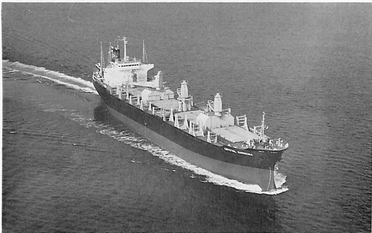
CRYSTAL GARDENIA (自動車兼ばら積運搬船) 船主 Naviera Mercurio S.A. (パナマ) 造船所 株式会社金指造船所 総噸数 11,460.14噸 純噸数 7,463.52噸 遠洋 船級 NK 載貨重量 17,914.75噸 全長 155.10m 長(垂)146.00m 幅(型)22.80m 深(型) 12.65m 吃水 9.221 満載排水量 24,036.25噸 凹甲板型 主機 三井B&W 7K62E F型ディーゼル機関1基 出力 8,600PS×140RPM 燃料消費量 33.7t/d 航続距離 15,000海里 速力 14.7ノット 汽罐CPDB-12型 発電機 AC445V×480KW×2台 貨物倉(ベール)21,472.62m 3 (グリーン)22,325.66m 3 清水倉 461.09m 3 燃料油倉 A 170.01m 3 C 1,480.56m 3 乗員 32名 工期 47-7-22, 47-11-7, 48-1-30 設備 B&V カーデッキ, カーエレベーター 4台装備 ロールオン/オフ式
