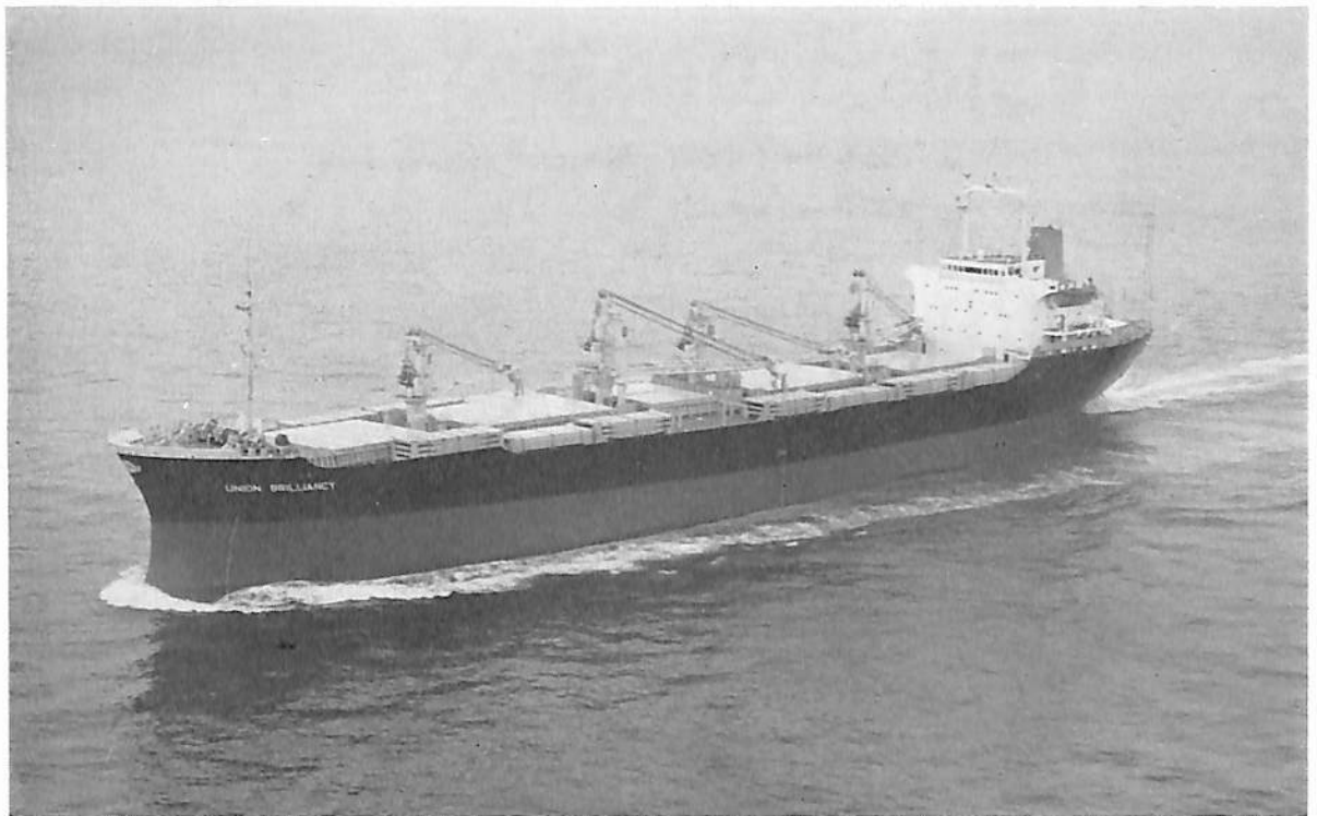
UNION BRILLIANCY (貨物船) 船主 International Union Lines Lid (リベリア) 造船所 佐野安船渠株式会社 総噸数 12,131.80噸 遠洋 船級 AB 載貨重量 20,814噸 全長 156.89 m 長(垂) 148.00 m 幅(型) 22.80 m 深(型) 13.50 m 吃水 9.88 m 凹甲板船 主機 三井 B&W 8 K 62 EF 型ディーゼル機関 1 基 出力(最大) 10,700 PS×144 RPM 航続距離 13,700 海里 速力 15.1 ノット 汽鐘 コクラン型 発電機 AC 400KVA×450 V×3 貨物倉(ベール) 23,857 m 3 (グリーン) 27,209 m 3 自動車搭載 164 台 乗員 42 名 工期 47-11-10, 48-2-9, 48-4-23 設備 揚錨機電動油圧 24.6 kt×9m/ntin×1 ジブクレーン電動 10 kt×18mR×2, 20 kt×18mR×2
