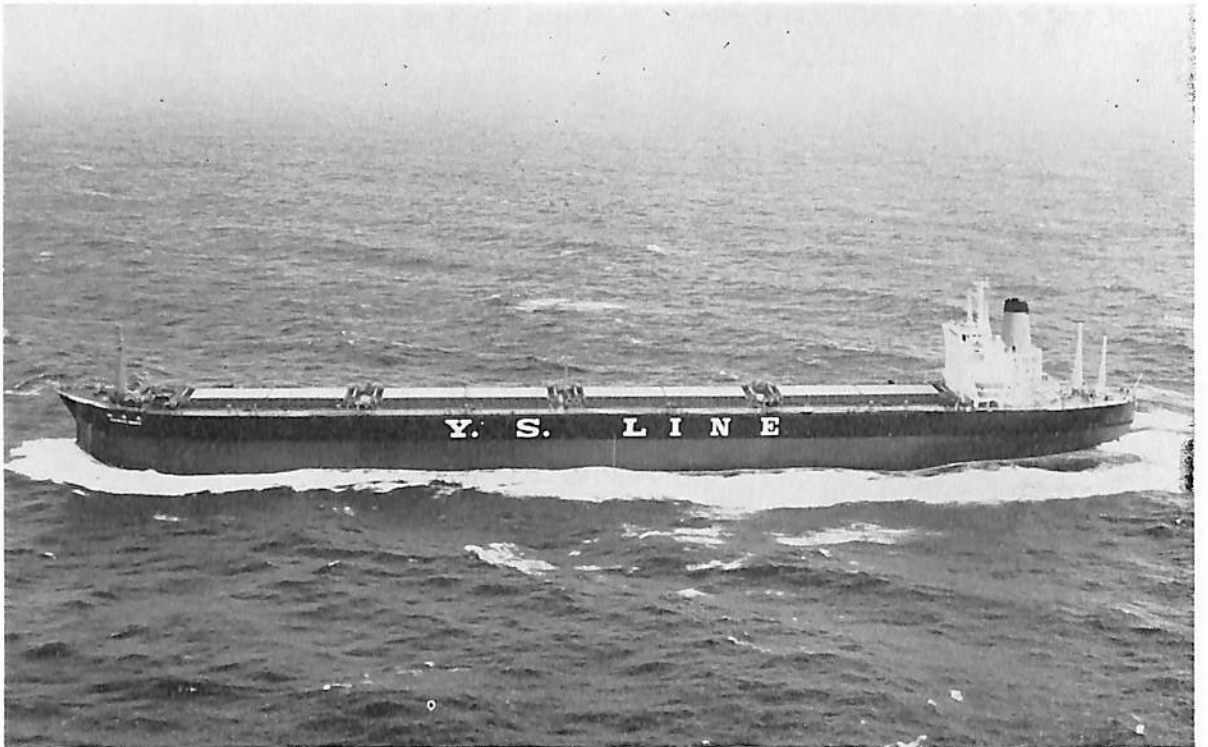
神 洋 丸 (鉱石運搬船) 船主 山下新日本汽船株式会社, 玉井商船株式会社 造船所 三井造船・玉野造船所 全長 259.347 m 長(長) 249.00 m 幅(型) 39.60 m 深(型) 22.00 m 吃水 16.152 m 総噸数 63,145.18 噸 載貨重量 116,170 噸 貨物倉 65,860.3 m 3 速力(試) 17.28 ノット 主機 三井 B&W 9 K 84 EF 型ディーゼル機関 1 基 出力(連続最大) 23,200 PS×114 RPM 乗員 32 名 船級 NK 工期 47-10, 48-1, 48-4-12
