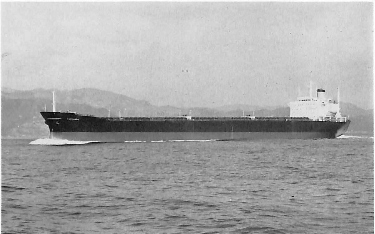
CARYANDA (ばら積貨物船) 船主 Seaways Transports Ltd (リベリア) 造船所 日立造船・舞鶴工場 総噸数 34,067.14 噸 純噸数 26,524 噸 遠洋 船級 AB 載貨重量 60,290 噸 全長 225.055 m 長(垂) 215.00 m 幅(型) 32.20 m 深(型) 17.80 m 吃水 12.4365 m 満載排水量 71,818 噸 一層甲板船 主機 日立スルザー 7 RND 76 型ディーゼル機関 1 基 出力 12,600 PS×118 RPM 燃料消費量 48.28 t/d 航続距離 23,300 海里 速力 14.80 ノット 貨物倉(グリーン) 74,191.3 m 3 燃料油倉 3,597.64 m 3 清水倉 440.38 m 3 乗員 45 名 工期 47-8-3, 47-11-23, 48-3-14
