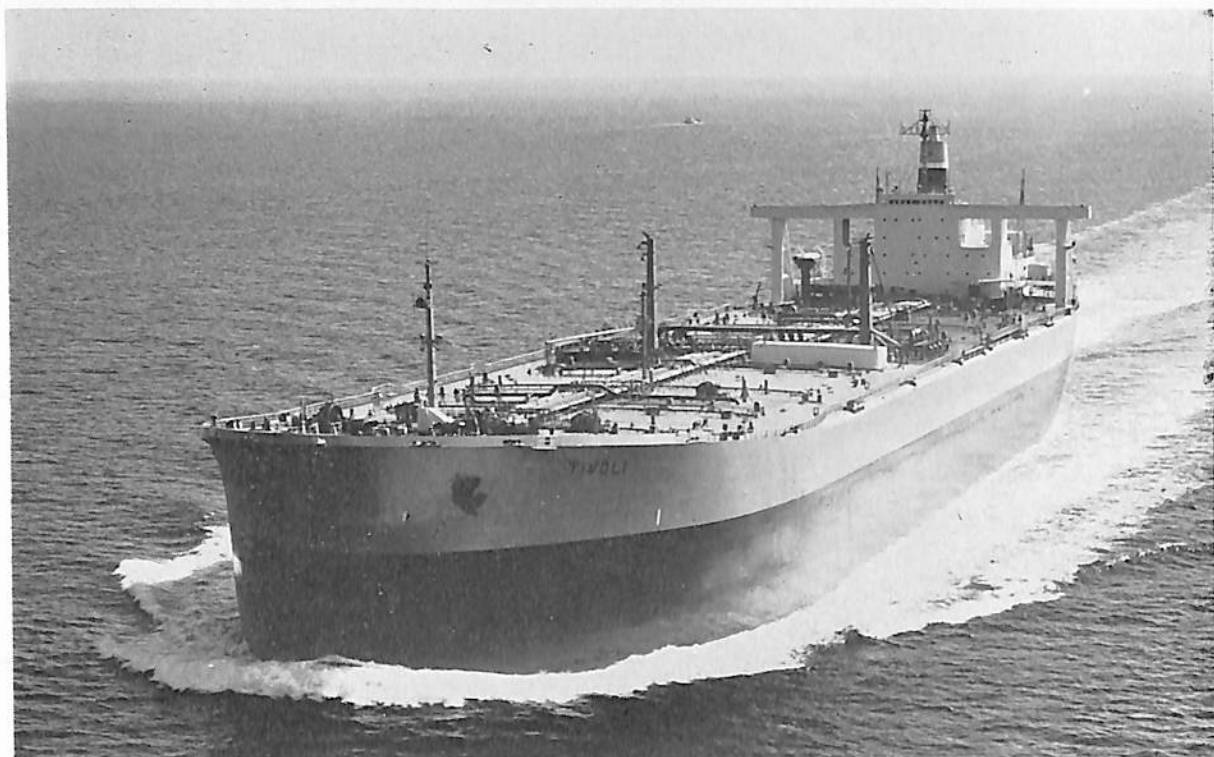
TIVOLI (油槽船) 船主 Leo Transport Corporation (リベリア) 造船所 川崎重工業・坂出工場 総噸数 104,918.43 噸 純噸数 88,071.37 噸 遠洋 船級 BV 載貨重量 231,797 噸 全長 319.30 m 長(垂) 305.00 m 幅(型) 53.00 m 深(型) 25.30 m 吃水 19.5365 m 満載排水量 266,205 噸 平甲板船 主機 川崎 UA-366 型タービン 1 基 出力 35,000 PS×89RPM 燃料消費量 175.73 t/d 航続距離 16,900 海里 速力 16.11 ノット 汽罐 川崎 UMG 72/56 ×2 型 燃料油倉 8,561.63 m 3 清水倉 130.94 m 3 乗員 38 名 工期 47-9 -5, 47-12-28, 48-4-26
