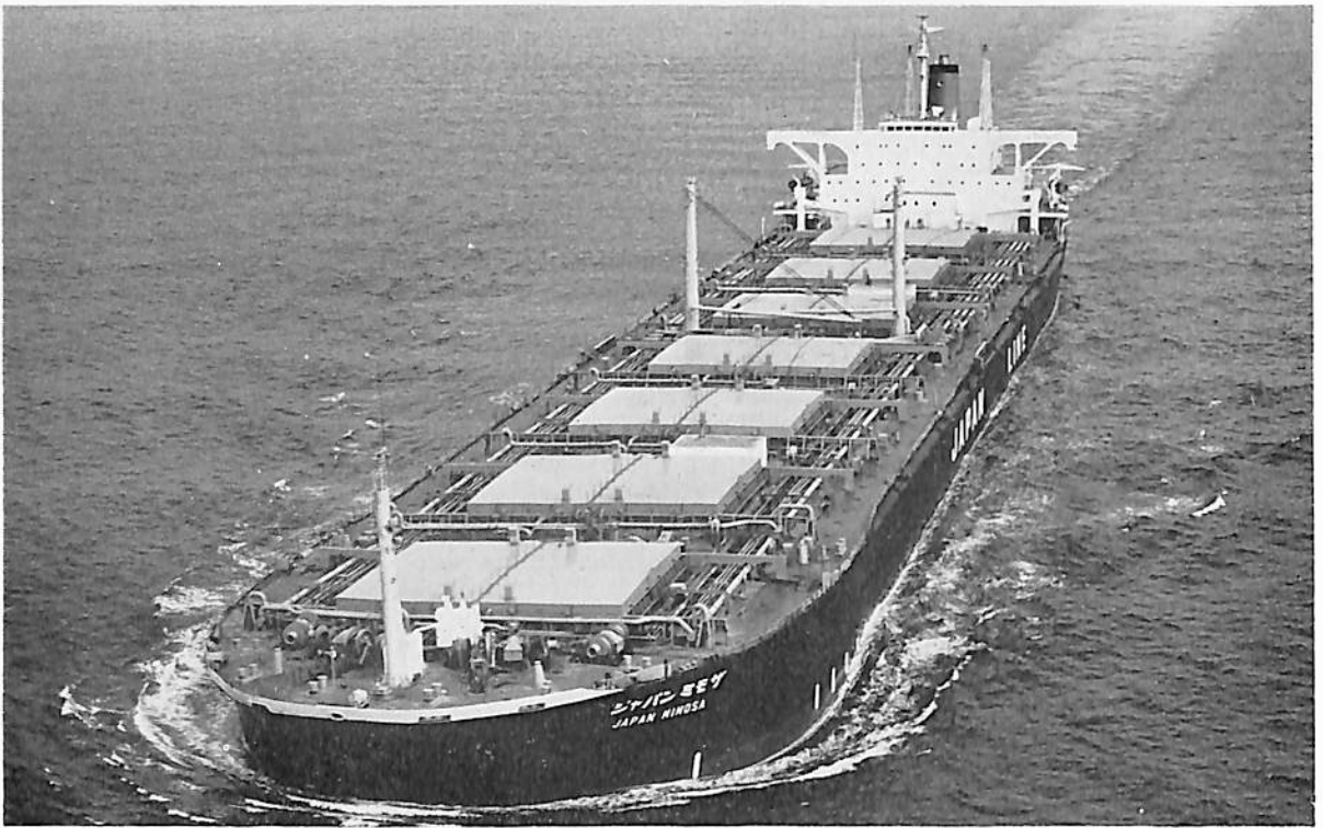
ジャパン ミモザ (JAPAN MIMOSA) (鉱石/石炭/原油運搬船) 船主 ジャパンライン株式会社 造船所 住友重機械工業・追浜造船所 総噸数 96,101.61 噸 純噸数 75,207.07 噸 遠洋 船級 NK 載貨重量 168,367 噸 全長 297.50 m 長(垂) 285.00 m 幅(型) 47.40 m 深(型) 24.80 m 吃水 17.574 m 満載排水量 200,509 噸 平甲板船 主機 住友-スタルラバ AP タービン 1 基 出力 25,800 PS×83 RPM 燃料消費量 129 t/d 離距続航 26,000 海里 速力 15.50 ノット 汽罐 二胴水管式 60 t/h×2 貨物倉(グリーン) 157,255 m 3 貨油倉 211,374 m 3 燃料油倉 10,453 m 3 清水倉 372 m 3 乗員 40 名 工期 47-8-9, 47-12-8, 48-3-29
