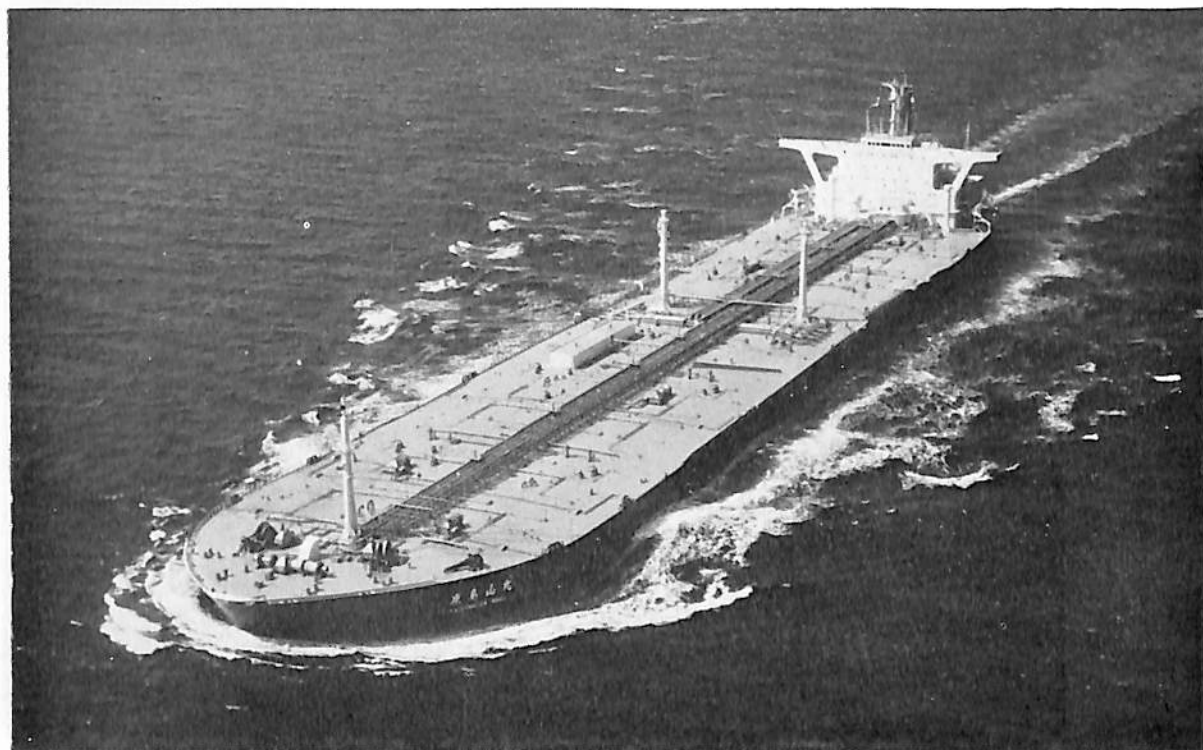
鹿島山丸 (油槽船) 船主 大阪商船三井船舶株式会社, 日本海汽船株式会社 造船所 日立造船・堺工場 総噸数 120,680.52 噸 純噸数 89,549.80 噸 遠洋 船級 NK 載貨重量 237,653 噸 全長 324.00 m 長(垂) 310.00 m 幅(型) 53.00 m 深(型) 25.00 m 吃水 19.44 m 一層甲板船 主機 日立 US-360 型タービン 1 基 出力 32,400 PS×87 RPM 燃料消費量 160.2 t/d 航続距離 16,225 海里 速力 15.54 ノット 汽罐 日立 \frac{72}{51} UA 型 51,000 kg×62 kg/cm 2 g×2 貨油倉 282,663.5 m 3 燃料油倉 8,172.3 m 3 清水倉 610.6 m 3 乗員 34 名 工期 47-7-27, 47-12-28, 48-3-31
