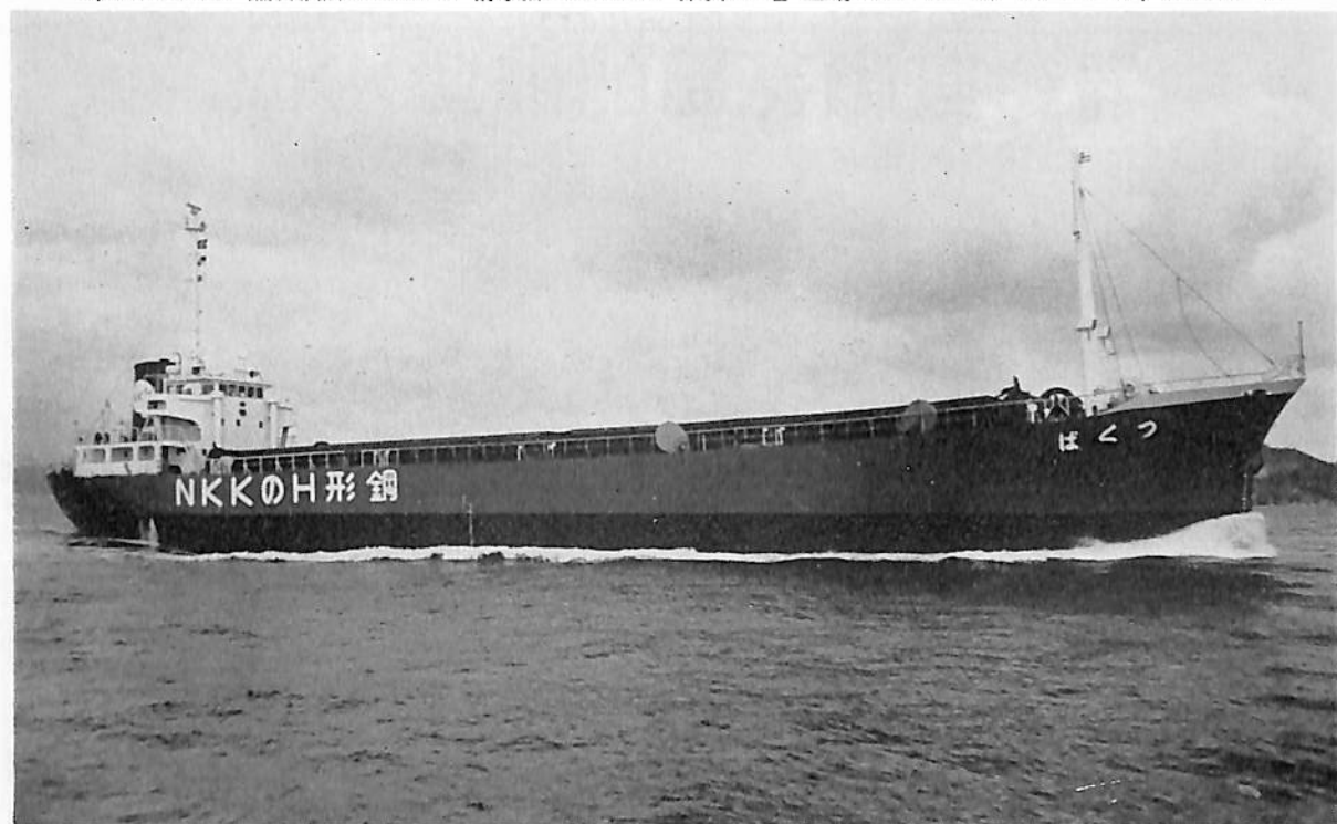
つくば (貨物船) 船主 正栄汽船株式会社 造船所 今治造船株式会社 総噸数 999.10 噸 純噸数 475.40 噸 沿海 載貨重量 3,175.83 噸 全長 82.00m 長(垂) 77.00m 幅(型) 12.50m 深(型) 5.75m 吃水 5.662m 満載排水量 4,185.00 噸 全通船楼甲板型 主機 榎田鉄工所 ESHC 640 型ディーゼル機関 1 基 出力 1,870 PS×279 RPM 燃料消費量 7.85 t/d 航続距離 5,880 海里 速力 12.05 ノット 汽罐 5 kg/cm 2 400 kg/H 1 基 発電機 250 KVA×2 貨物倉(ベール) 4,289.08 m 3 (グリーン) 4,630.89 m 3 燃料油倉 206.50 m 3 清水倉 40.04 m 3 乗員 12 名 工期 47-10-30, 48-2-16, 48-3-14
