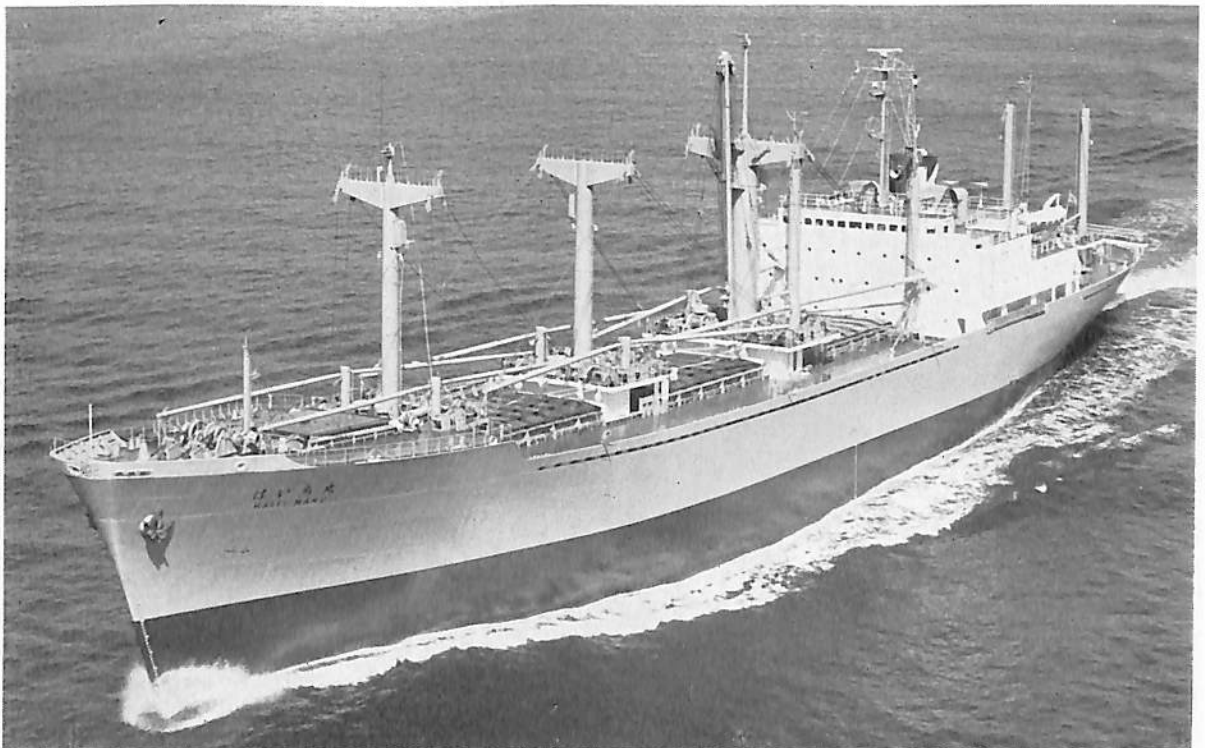
はいち丸 (貨物船) 船主 川崎汽船株式会社 造船所 日立造船・向島工場 総噸数 8,842.03 噸 純噸数 5,258.63 噸 遠洋 船級 NK 載貨重量 12,183 噸 全長 141.00 m 長(垂) 130.218 m 幅(型) 20.80 m 深(型) 12.50 m 吃水 9.179 m 満載排水量 16,549 噸 長船首楼付平甲板船 主機 日立 B&W 6 K 62 EF 型ディーゼル機関 1 基 出力 7,055 PS×137 RPM 燃料消費量 約 28.1 t/d 航続距離 約 13,900 海里 速力 16.1 ノット 汽罐 日立プレミングボイラ No. 3 発電機 AC 450 V, 600 KVA, 900 PS×2 貨物倉(ベール) 17,205 m 3 (グリーン) 18,602 m 3 燃料油倉 1,004.36 m 3 清水倉 364.63 m 3 乗員 36 名(外 2 名) 工期 47- 10-25, 48-1-9, 48-3-17
