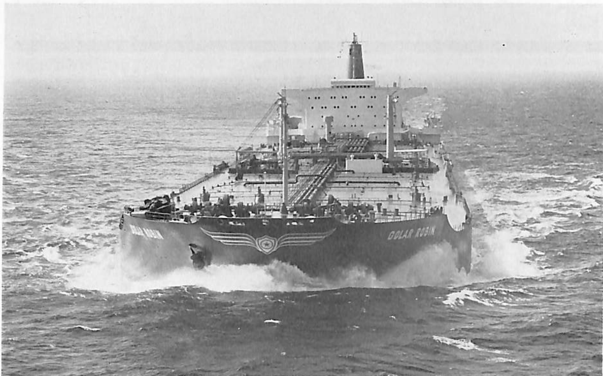
GOLAR ROBIN (油槽船) 船主 Ocean Oil Yonchu Inc. (ノルウェー) 造船所 川崎重工業・坂出工場 総噸数 98,884.57 噸 純噸数 81,005.06 噸 遠洋 船級 NV 載貨重量 215,923 Lt 全長 327.00 m 長(垂) 313.00 m 幅(型) 48.20 m 深(型) 25.20 m 吃水 19.597 m 満載排水量 248,703 Lt 船首楼付平甲板船 主機 川崎 UR-315 型タービン 1 基 出力 28,000 PS×88 RPM 燃料消費量 125.1 t/d 航続距離 19,144 海里 速力 15.58 ノット 汽罐 川崎 UFR 87/77 型 燃料油倉 6,928.6 m 3 清水倉 227.2 m 3 乗員 41 名 工期 47-7-5, 47-11-7, 48-3-1 設備 ノズルプロペラー, イナートガスシステム
