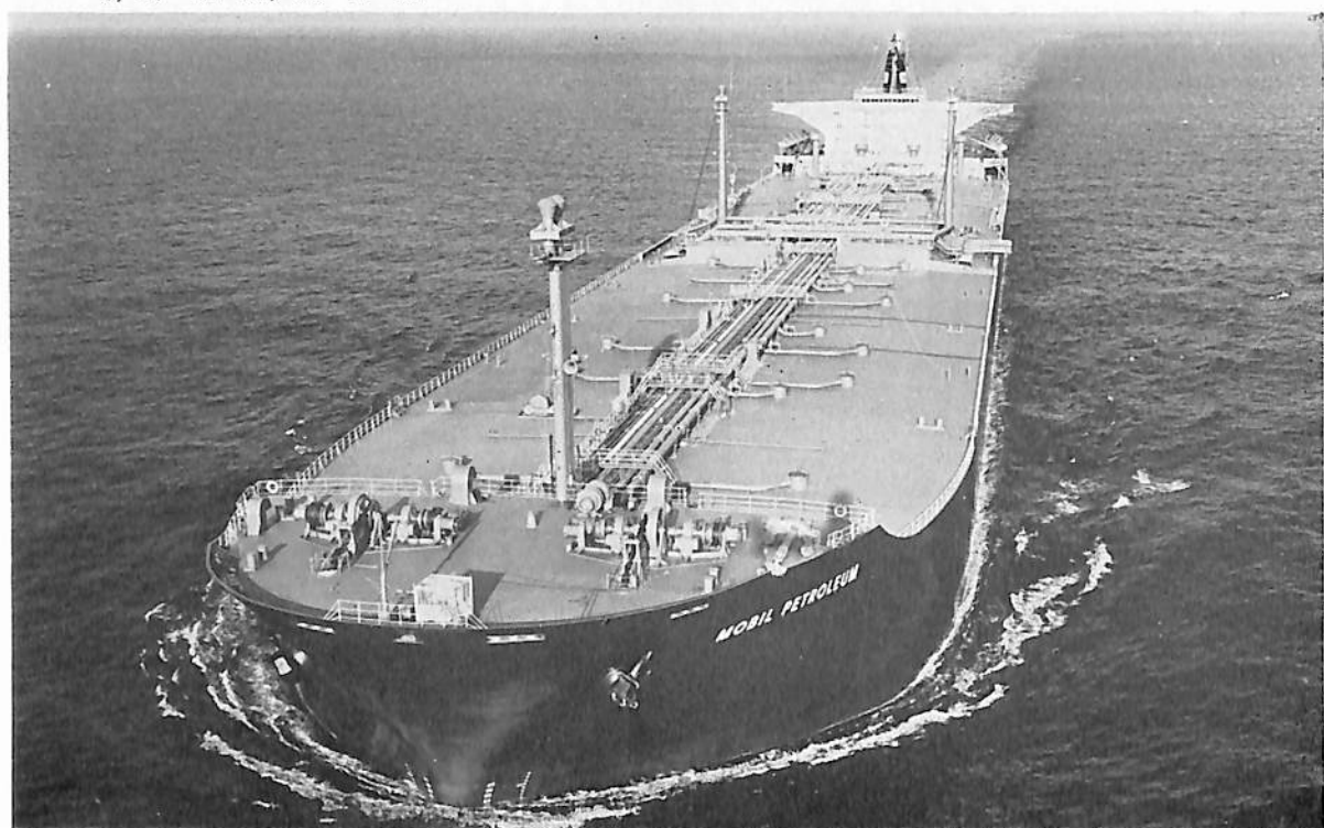
MOBIL PETROLEUM (油槽船) 船主 Mobil Shipping & Transportation Company (リベリア) 造船所 佐世保重工業・佐世保造船所 全長 326.00 m 長(垂) 313.00 m 幅(型) 48.20 m 深(型) 25.50 m 吃水 19.331 m 総噸数 107,624.71 噸 載貨重量 211,807 噸 速力(試) 16.9 ノット (航) 16.5 ノット 主機 IHI-GE スチームタービン 1 基 出力 30,000 PS 船級 AB 工期 47-10, 47-12, 48-4-10
