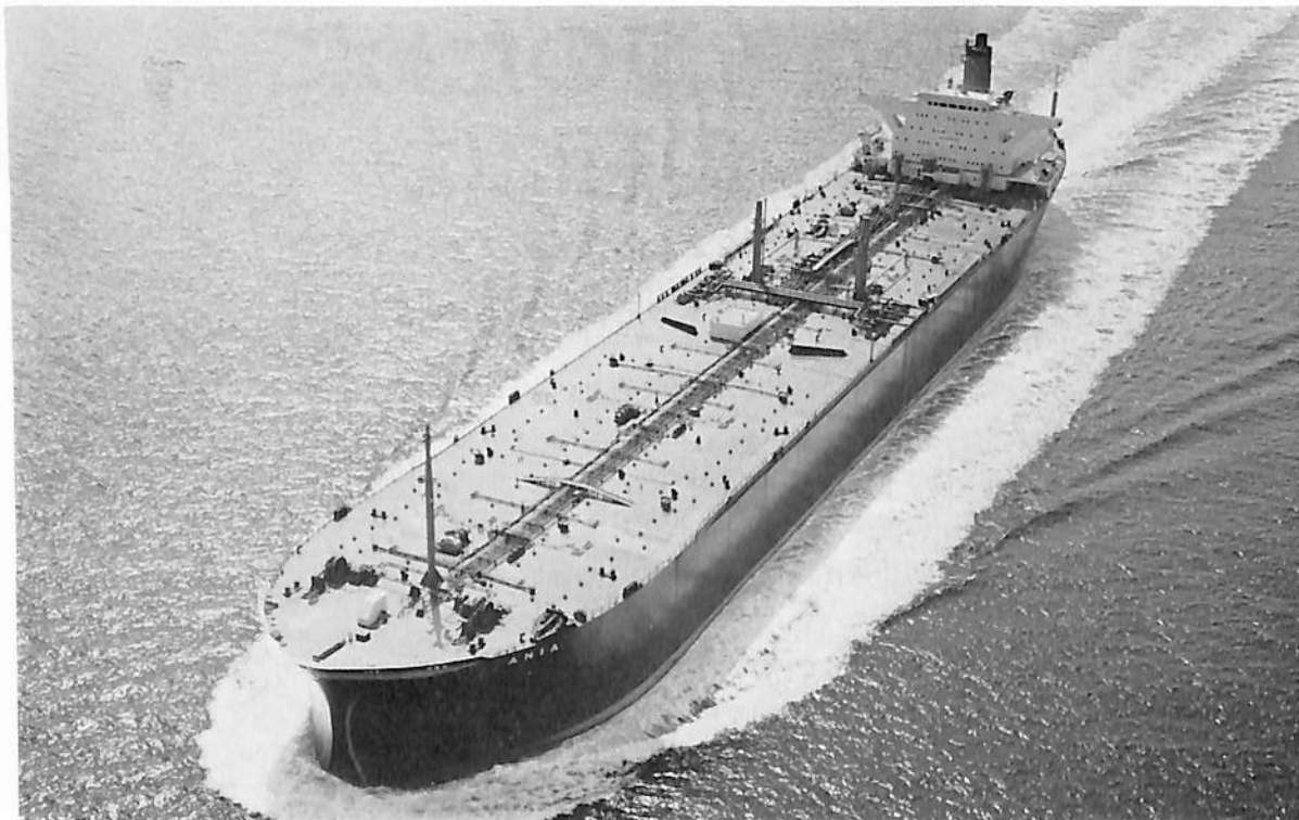
ANIA (油槽船) 船主 Global Bulk Oil Corporation (リベリア) 造船所 日立造船・因島工場 総噸数 60,850.22 噸 純噸数 46,104 噸 遠洋 船級 AB 載貨重量 128,193 噸 全長 266.70 m 長(垂) 255.00 m 幅(型) 41.40 m 深(型) 22.20 m 吃水 55'-2 1 / 8 " 満載排水量 149,669 噸 平甲板船 主機 日立 B&W 9K 84 EF 型ディーゼル機関 1 基 出力(最大) 23,200 PS×114 RPM (常用) 21,100 PS×110 RPM 燃料消費量 77.5 t/d 航続距離 21,000 海里 速力(試) 15.57 ノット (航) 14.6 ノット 貨油倉 151,039.93 m 3 燃料油倉 4,934.15 m 3 清水倉 482.76 m 3 乗員 47 名 工期 47-8-28, 47-12-5, 48-3-27
