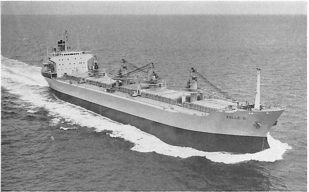
KOLLE D (ばら積貨物船) 船主 Nauru Local Government Council(ナウル) 造船所 株式会社 名村造船所 総噸数 19,564.03 噸 純噸数 14,636.38 噸 遠洋 船級 LR 載貨重量 32,464 噸 全長 184.02 m 長(垂) 175.00 m 幅(型) 25.00 m 深(型) 15.40 m 吃水 10.862 m 満載排水量 39,697 噸 船首接付平甲板型 主機 三菱スル ザー 7RND 68 型ディーゼル機関 1 基 出力 9,820 PS×142 RPM 燃料消費量 37.6 t/d 航続距離 13,400 海里 速力 14.7 ノット 発電機 912.5 KVA(730 KW)×2 貨物倉(グリーン) 37,623 m 3 燃料油倉 1,687.6 m 3 清水倉 184.6 m 3 乗員 51 名 工期 47-8-28, 47-12-9, 48-3-31
