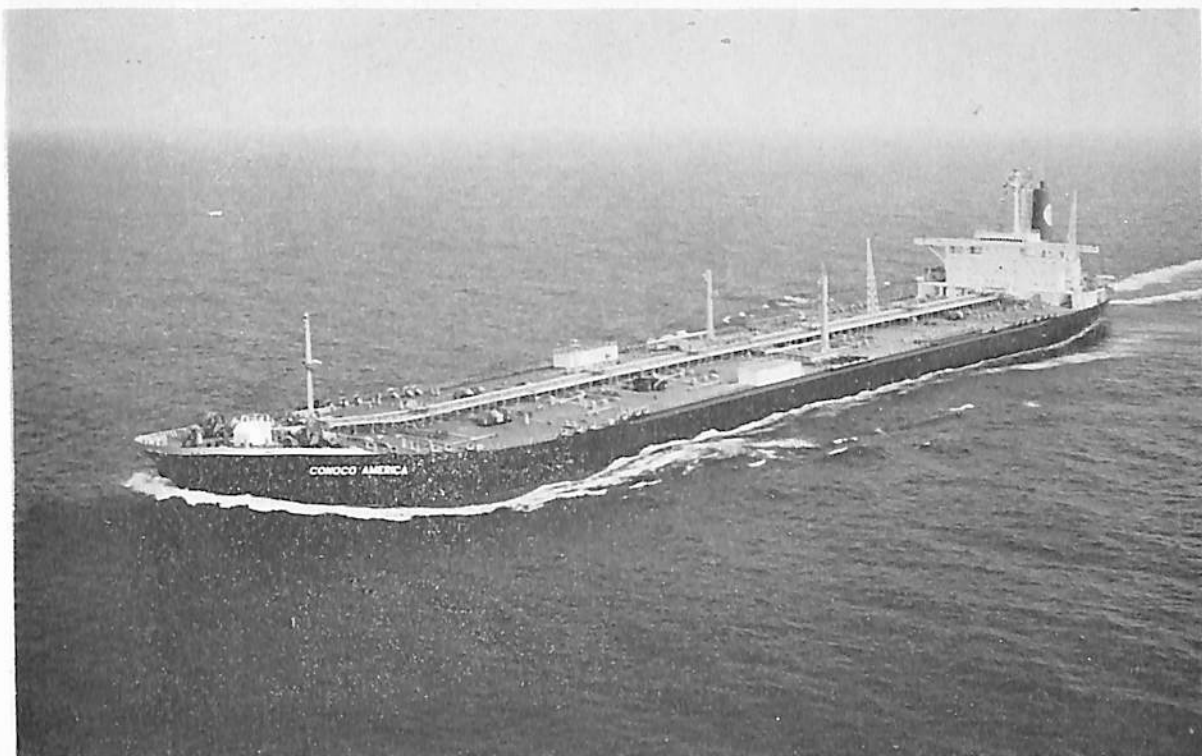
CONOCO AMERICA (油槽船) 船主 Maritime Tankers Corporation (リベリア) 造船所 石川島播磨重工業・呉造船所 総噸数 119,626 噸 純噸数 99,113 噸 遠洋 船級 AB 載貨重量 276,219 噸 全長 337.058 m 長(垂) 320.00 m 幅(型) 54.50 m 深(型) 27.00 m 吃水 69'— \frac{3}{4} " 平甲板船 主機 IHI-スチームタービン 1 基 出力 36,000PS×80 RPM 燃料消費量 173.04 t/d 航続距離 15,500 海里 速力 16.18 ノット 汽罐 IHI-F.W. two-drum MDM×2 貨油倉 325,049 m 3 燃料油倉 8,702 m 3 清水倉 650 m 3 乗員 35 名(外 8 名) 工期 47-10-19, 48-1-13, 43-4-20
