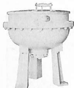
ライスボイラー
