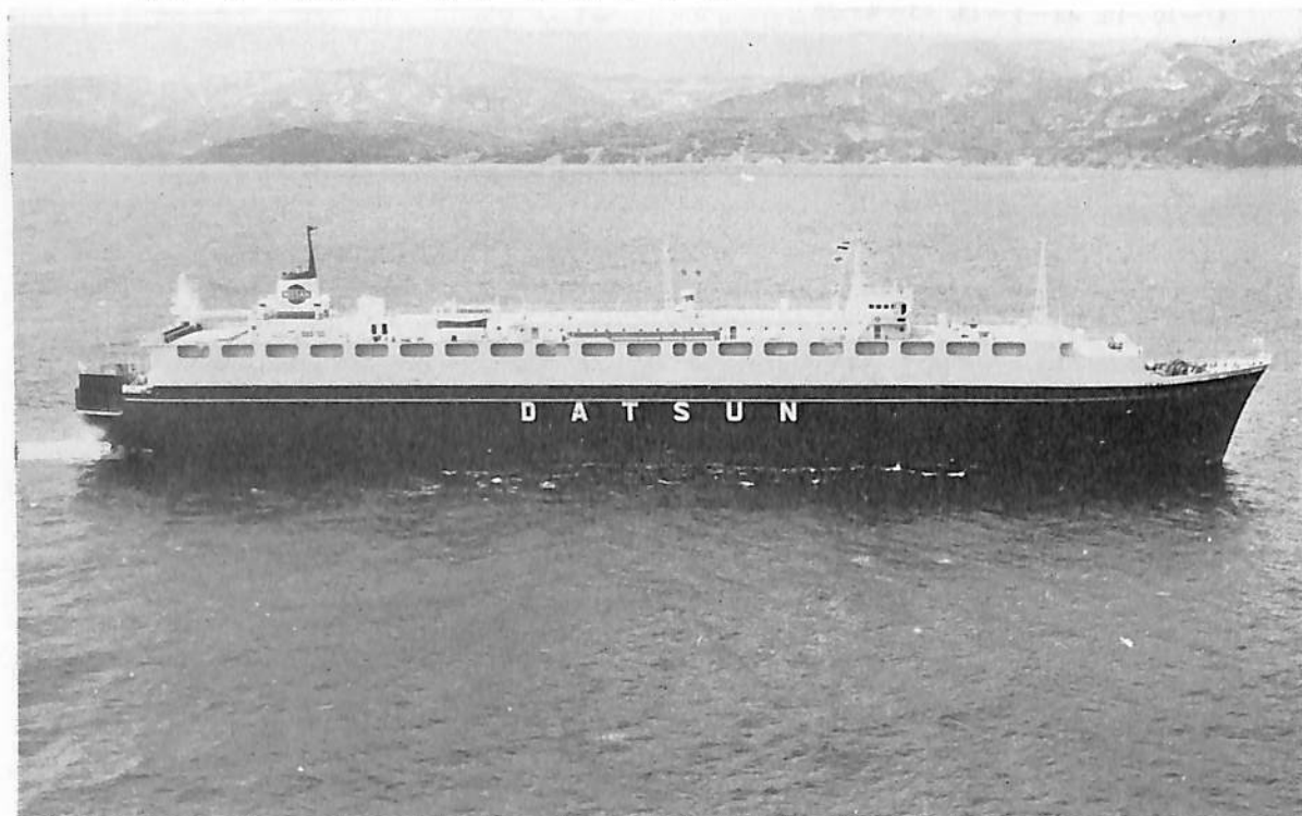
相 模 丸 (自動車専用船) 船主 日之出汽船株式会社, 昭和海運株式会社 造船所 日立造船・舞鶴工場 総噸数 6,828.01 噸 純噸数 2,717.9 噸 遠洋 船級 NK 載貨重量 8,678 噸 全長 174.50 m 長(垂) 164.00 m 幅(型) 25.40 m 深(型) 8.10 m 吃水 7.20 m 満載排水量 17,086 噸 主機 日立 B&W 9 K 62 EF 型ディーゼル機関 1 基 出力 10,540 PS×137 RPM 燃料消費量 43.56 t/d 航続距離 13,650 海里 速力 18.18 ノット 汽罐 日立フレミングボイラ No.3×1 発電機 500 KVA, AC 450 V, 60 Hz×3 自動車搭載甲板面積 25,672.38 m 2 燃料油倉 1,508.47 m 3 清水倉 618.65 m 3 乗員 30 名(外 2 名) 工期 47-8-7, 47-12-21, 48-3-26
