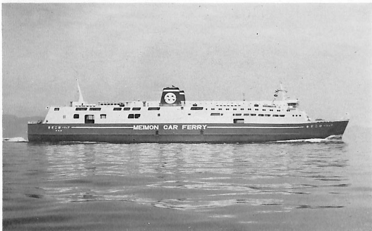
フェリー はこぎき (自動車航送客船) 船主 名門カーフェリー株式会社 造船所 尾道造船株式会社 総噸数 7,267.29 噸 純噸数 3,532.06 噸 沿海 載貨重量 2,919.90 噸 全長 138.60 m 長(垂) 128.00 m 幅(型) 22.14 m 深(型) 13.20 m 吃水 5.887 m 満載排水量 8,522.85 噸 覆甲板型, 傾斜船型 主機 三菱横浜 V 型 4 サイクル単動トランクピストン過給機付ディーゼル機関1基 出力 6,840 PS×391/193 RPM 燃料消費量 49.0 t/d 航続距離 2,164 海里 速力 19.1 ノット 汽罐 クレイトン式3台 発電機 570 KW×3台 旅客定員 貴賓室 4名, 特1等12名, 1等157名, 特2等90名, 2等395名, 運転手室52名, 旅客合計710名 車輛 トラック108 台 乗用車63台 燃料油倉 318.80 m 3 清水倉 215.23 m 3 乗員 61 名 工期 47-12-19, 48-3-6, 48-5-28
