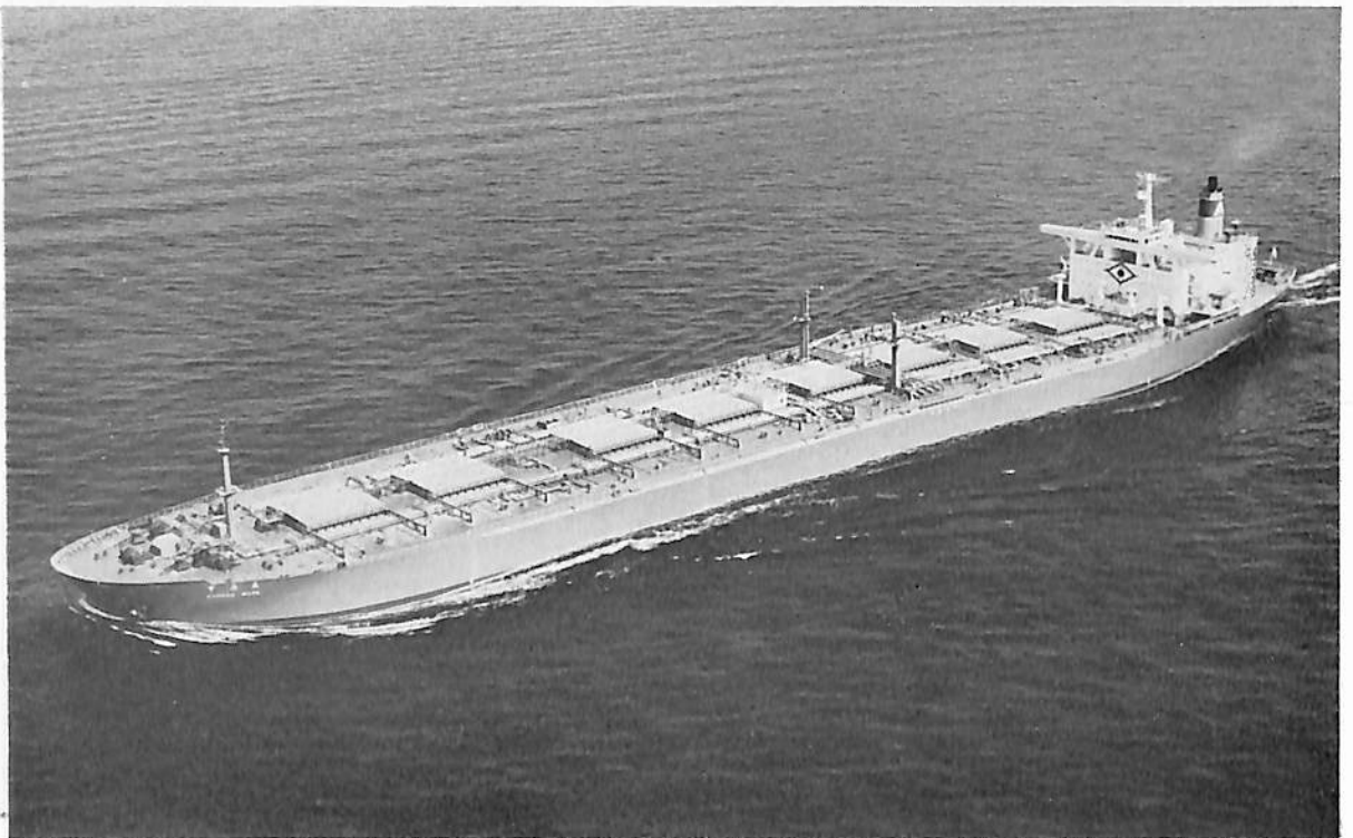
甲 南 丸 (鉾石兼油槽船) 船主 旭海運株式会社, 日本郵船株式会社 造船所 三菱重工業・横浜 造船所 総噸数 95,004.62 噸 純噸数 67,030.88 噸 遠洋 船級 NK 載貨重量 164,517 噸 全長 294.95 m 長 (垂) 280.00 m 幅(型) 47.40 m 深(型) 24.80 m 吃水 17.50 m 平甲板船 主機 三菱船用 2 段減速装置付スチ ームタービン 1 基 出力 28,000 PS×88 RPM 燃料消費量 139 t/d 航続距離 28,400 海里 速力 16.0 ノット 汽 缶 三菱 CE.2 胴水管 61.5 kg/cm 2 65 t/h×2 貨物倉(グレーン) 94,999 m 3 貨油倉 207,477 m 3 燃料油倉 11,777 m 3 清水倉 526 m 3 乗員 48 名 工期 47-7-28, 48-1-25, 48-4-2 同型船 CYPRESS KNG, EASTERN SPRIT
