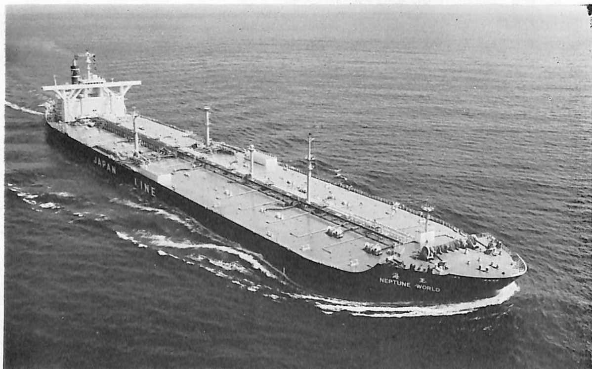
NEPTUNE WORLD (油槽船) 船主 Liberian Zephyr Transports Inc. (リベリア) 造船所 三菱重工業長崎造船所 総噸数 105,787.09 噸 純噸数 87,227.40 噸 遠洋 船級 BV 載貨重量 237,367 噸 全長 321.82 m 長(垂) 304.00 m 幅(型) 52.40 m 深(型) 25.70 m 吃水 19.849 m 船首樓付平甲板船 主機 三菱二段減速裝置付タービン 1 基 出力 36,000 PS×90 RPM 燃料消費量 164.0 t/d 航続距離 約 17,000 海里 速力 15.8 ノット 汽缸 三菱 C.E 型×2 発電機 1×1,400 KW, AC 450 貨油倉 289,267.3 m 3 燃料油倉 8,271.1 m 3 清水倉 760.1 m 3 乗員 50 名 工期 47-7-20, 47-11-28, 48-5-9
