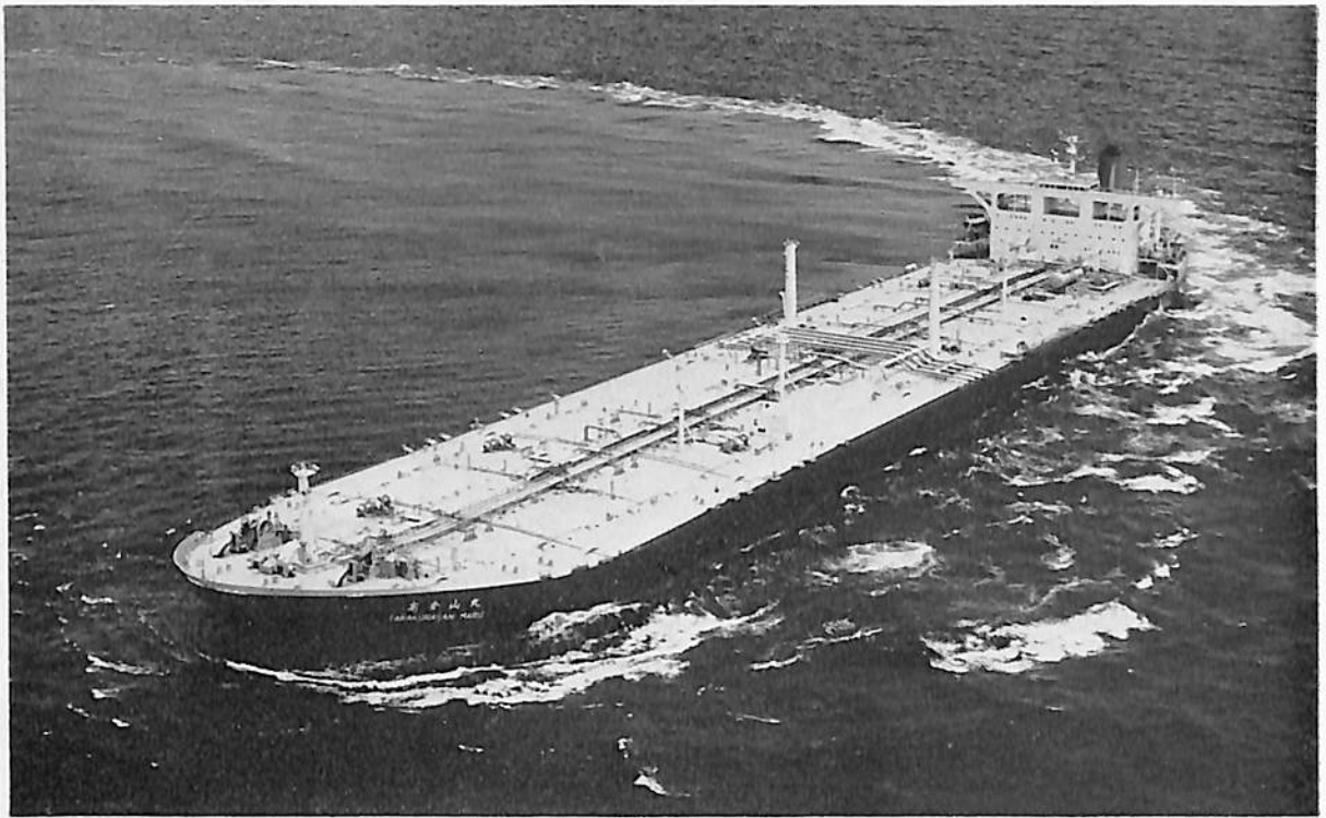
高倉山丸(油槽船) 船主 大阪商船三井船舶株式会社 造船所 三井造船・千葉造船所 総噸数 133,926.69噸 純噸数 101,968.85噸 遠洋 船級 NK 載貨重量 272,494 噸 全長 331.50 m 長(垂) 318.00 m 幅(型) 56.00 m 深(型) 26.40 m 吃水 20.55 m 満載排水量 311,164 噸 平甲板型 主機 三井 B& W 10 K 98 FF 型ディーゼル機関 1 基 出力 32,300 PS×97.5 RPM 燃料消費量 127 t/d 航続距離 16,100 海里 速力 15.00 ノット 汽罐 三井 2 胴式水管ボイラー 1 台 発電機 1120 PS×2 基 貨油倉 326,364.4 m 3 燃 料油倉 7,420.2 m 3 清水倉 652.4 m 3 乗員 35 名 工期 47-9-27, 48-2-15, 48-5-21
