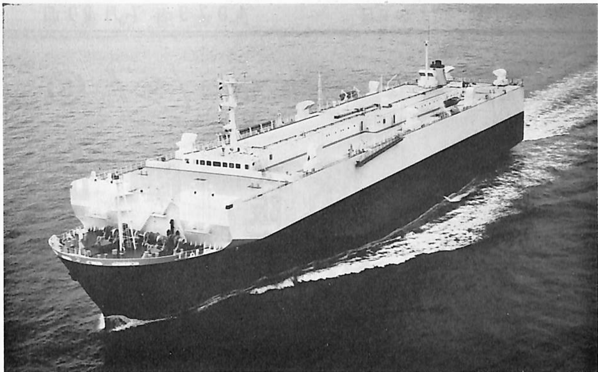
第七ぶりんす丸(自動車運搬専用船) 船主 株式会社 パシフィック・リース, 日産プリンス海運株式会社 造船所 三菱重工業・神戸造船所 総噸数 8,536.90 噸 純噸数 4,044.64 噸 遠洋 船級 NK 載貨重量 8,871.00 噸 全長 169.115 m 長(垂) 160.00 m 幅(型) 25.60 m 深(型) 10.01 m 吃水 7.22 m 満載排水量 16,167 噸 全 通船楼船 主機 三菱 MAN V9V 40/54 型ディーゼル機関 1 基 出力 8,865 PS×145 RPM 燃料消費量 32.4 t/d 航続距離 約 12,500 海里 速力 17.0 ノット 発電機 687.5×450 V×2 小型乗用車積載台数 約 3,200 台 燃料油倉 1,530.3 m 3 清水倉 335.2 m 3 乗員 31 名 工期 47-8-10, 48-2-10, 48-5-22
