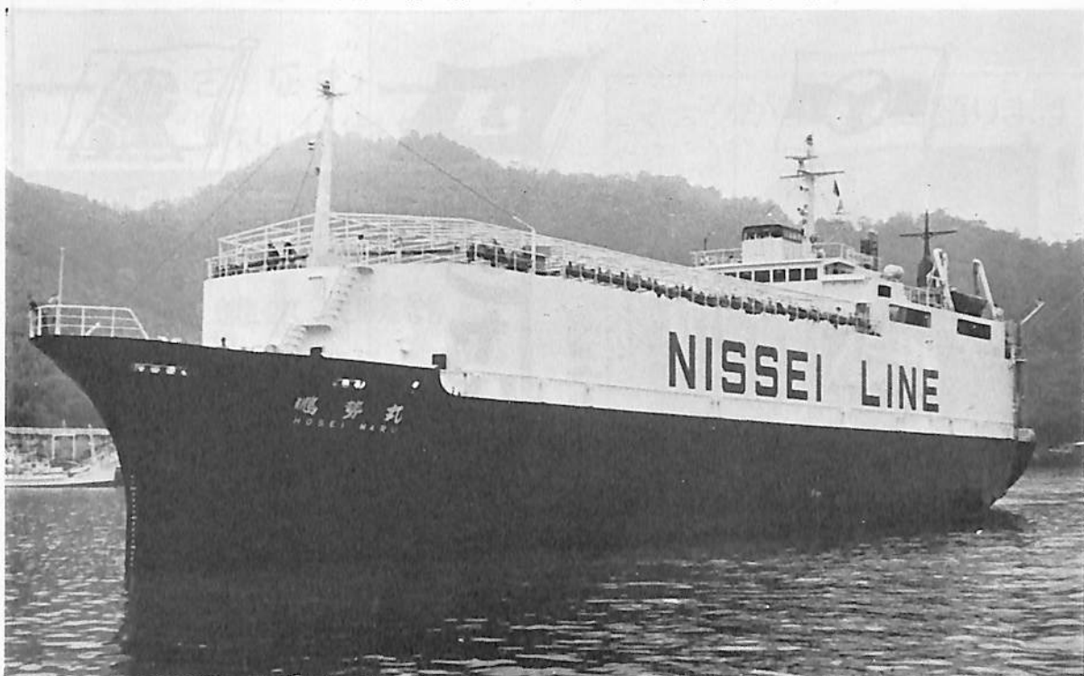
鰐勢丸(自動車専用船) 船主 株式会社 日本リース, 日勢海運株式会社 造船所 本田造船株式会社 総噸数 1,514.37 噸 純噸数 711.96 噸 近海 船級 JG 載貨重量 2,997.76 噸 全長 86.52 m 長(垂) 80.00 m 幅(型) 14.50 m 深(型) 8.30 m 吃水 5.014 m 満載排水量 4,458 噸 全通船楼甲板船 主機 楨田鉄工所 GSHC 641 型ディーゼル機関 1 基 出力 2,380 PS×276 RPM 燃料消費量 140 g/h/ps 航続距離 8,000 海里 速力 14.2 ノ ット 発電機 440 V×150 KVA×2 料燃油倉 A 42.7 m 3 C 297.7 m 3 清水倉 142.5 m 3 乗員 17 名 工期 47-12 48-4, 48-5, 設備 A デッキ 上下動(油圧)
