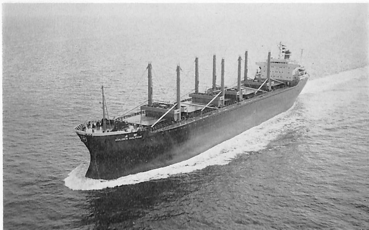
GOLDEN DOLPHIN (ばら積貨物船) 船主 Liberian Poniard Transports, Inc. (リベリア) 造船所 株式会社 大阪造船所 総噸数 19,654.24 噸 純噸数 13,871 噸 遠洋 船級 AB 載貨重量 34,093 噸 全長 185.500 m 長(垂) 175.000 m 幅(型) 26.000 m 深(型) 15.500 m 吃水 11.151 m 満載排水量 41,748 噸 凹甲板型 主機 IHI スル ザー 7 RND 68 型ディーゼル機関 1 基 出力 10,395 PS×144.8 RPM 燃料消費量 42.03 t/d 航続距離 約 16,110 海里 速力 14.6 ノット 発電機 AC 450 V×480 KVA 3 台 貨物倉(ベール) 41,242 m 3 (グリーン) 44,735 m 3 燃料油倉 2,164.9 m 3 清水倉 432.4 m 3 乗員 50 名 工期 47-12-7, 48-2-28, 48-5-10
