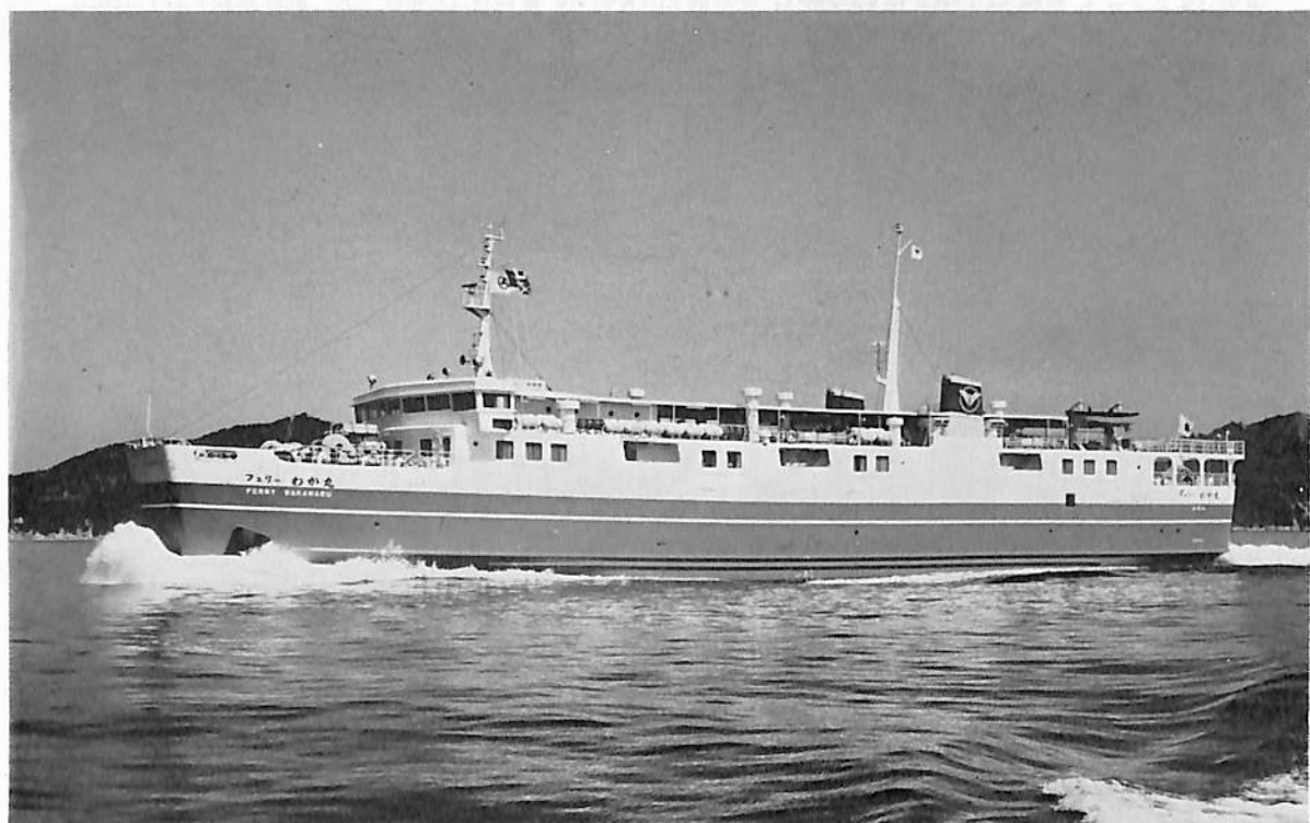
フェリーわか丸 (旅客兼自動車航送船) 船主 船舶整備公団, 南海汽船株式会社 造船所 内海造船株式会社 田熊工場 総噸数 1,655.12 噸 純噸数 642.46 噸 沿海 船級 JG 載貨重量 754.96 噸 全長 77.68 m 長(垂) 73.00 m 幅(型) 12.70 m 深(型) 5.20 m 吃水(計画満載) 3.70 m (夏期満載) 4.10 m 満載排水量(計画満載) 2,020.0 噸 (夏期満載) 2,342.0 噸 全通船楼船 主機 ダイハツ立形単動 4 サイクルランクピストン型排気タ ービン過給機付ディーゼル機関 1 基 出力 2,720 PS×682 RPM 燃料消費量 24.3 t/d 航続距離 1,090 海里 速力 16.75 ノット 汽罐 クレイトン WHO-75 発電機 312.5 KVA (250 KW)×3 旅客定員 800 名 (1 等 95 名 特 2 等 144 名 2 等 395 名 ベンチ 166 名) 燃料油倉 77.16 m 3 清水倉 72.38 m 3 乗員 50 名 工期 47-9, 48- 1, 48-4 設備 ヒーリングタンク, パウスラスタ (電動式スラスト 4.2 t (翼角 25°))
