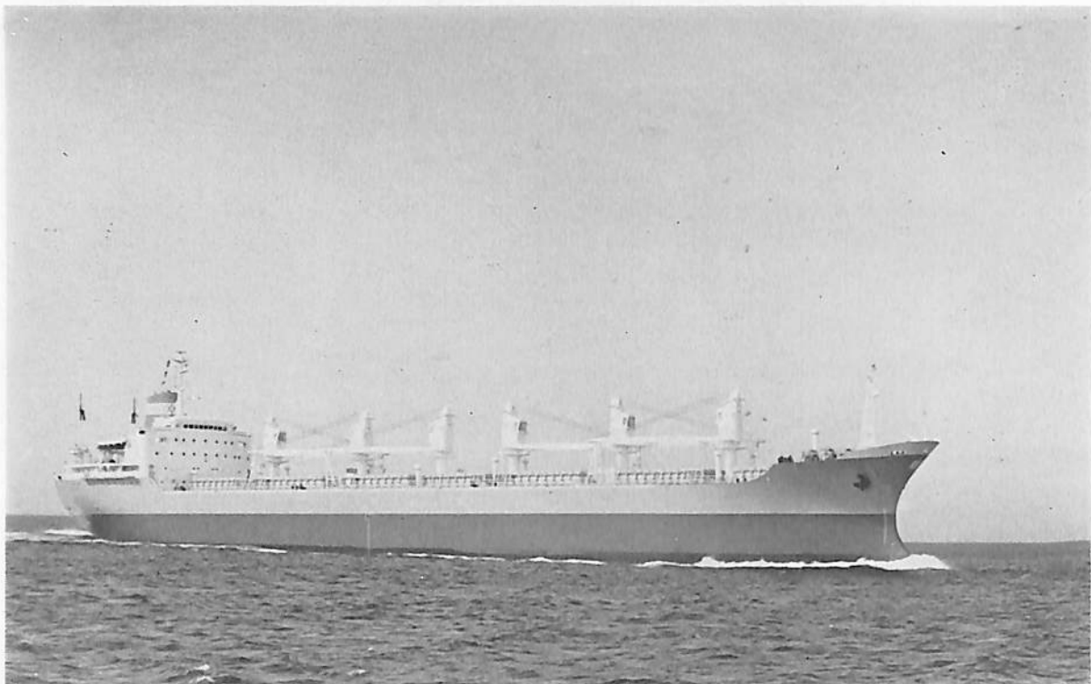
APEX (ばら積貨物船) 船主 Apex Shipping Corporation (イングランド) 造船所 函館ドック・室蘭製作所 総噸数 16,397.56 噸 純噸数 10,753.92 噸 遠洋 船級 LR 載貨重量 28,761 噸 全長 180.80 m 長(垂) 170.00 m 幅(型) 23.10 m 深(型) 14.50 m 吃水 35'-1/2" 満載排水量 35,241 噸 凹型甲板船 主機 IHI-スルザー 6 RND 76 型ディーゼル機関 1 基 出力 10,800 PS×118 RPM 燃料消費量 40.9 t/d 航続距離 16,300 海里 速力 15.1 ノット 汽罐 7 kg/m 2 G×1,500 kg/h×1 発電機 AC 368 KW×3 貨物倉(ベール) 33,329 m 3 (グリーン) 37,713 m 3 燃料油倉 2,214 m 3 清水倉 249 m 3 乗員 39 名 工期 47-9-21, 48-1-10, 48-4-6
