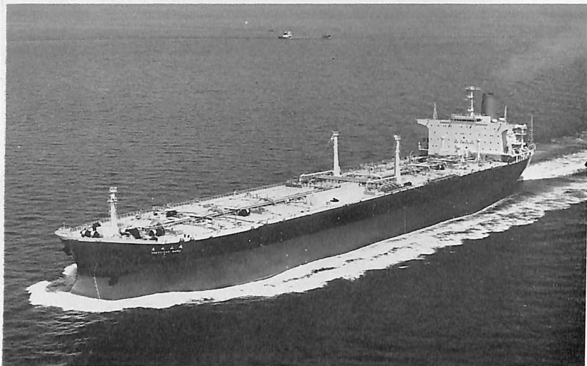
高城山丸(油槽船) 船主 大阪商船三井船舶株式会社, 松岡汽船株式会社 造船所 三井造船・玉野造船所 全長 271.00 m 長(長) 261.00 m 幅(型) 44.00 m 深(型) 22.40 m 吃水 17.029 m 総噸数 72,335.56 噸 載貨重量 139,138 噸 貨油倉 171,534.6 m 3 速力(試) 16.3 ノット 主機 三井 B&W 10 K 84 EF 型ディーゼル機関 1 基 出力(連続最大) 25,000 PS×114 RPM 乗員 32 名 船級 NK 工期 47-10, 47-12, 48-5-11
