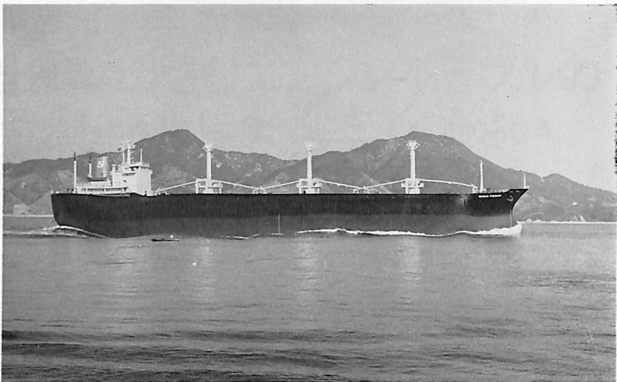
NAGAN PIONEER (ばら積貨物船) 船主 Mermaid Shipping Corporation S.A. (パナマ) 造船所 幸陽船渠株式会社 総噸数 14,035.97 噸 純噸数 9,157.85 噸 遠洋 船級 NK 載貨重量 26,610.03 噸 全長 177.20 m 長(垂) 164.90 m 幅(型) 22.80 m 深(型) 14.60 m 吃水 10.502 m 満載排水量 33,513.50 噸 凹甲板船 主機 IHI-スルザー 7RND 68 型ディーゼル機関 1 基 出力 10,400 PS×145 RPM 燃料消費量 39.16 t/d 航続距離 8,640 海里 速力 15.00 ノット 発電機 AC 440×500 KVA×2 貨物倉(ベール) 30,356.01 m 3 (グリーン) 31,339.07 m 3 燃料油倉 1,518.84 m 3 清水倉 255.44 m 3 乗員 40 名 工期 47-11-10, 48-1-10, 48-5-15
