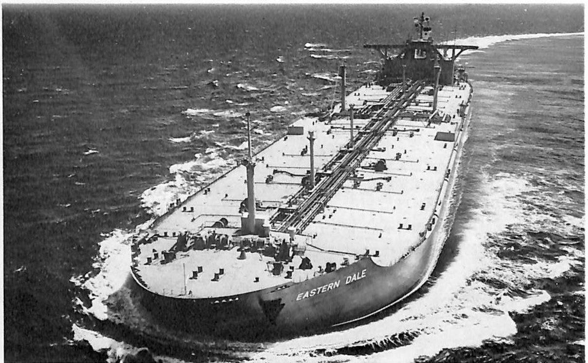
EASTERN DALE (油槽船) 船主 Union International Steamship Co. Ltd (リベリア) 造船所 三菱 重工業・長崎造船所 総噸数 117,570.49噸 純噸数 88,363.98噸 遠洋 船級 NK 載貨重量 236,780 噸 全長 321.82 m 長(垂) 304.00 m 幅(型) 52.40 m 深(型) 25.70 m 吃水 19.887 m 主機 三菱 2 段減速装置付ター ビン 1 基 出力 34,000 PS×90 RPM 燃料消費量 166.5 t/d 航続距離 29,000 海里 速力 15.8 ノット 汽罐 三菱 CE 61.5 kg/cm 2 g×2 発電機 AC 450 V 貨油倉 282,765.5 m 3 燃料油倉 14,010.0 m 3 清水倉 760.1 m 3 乗員 39 名 工期 47-9-20, 48-2-1, 48-5-22
