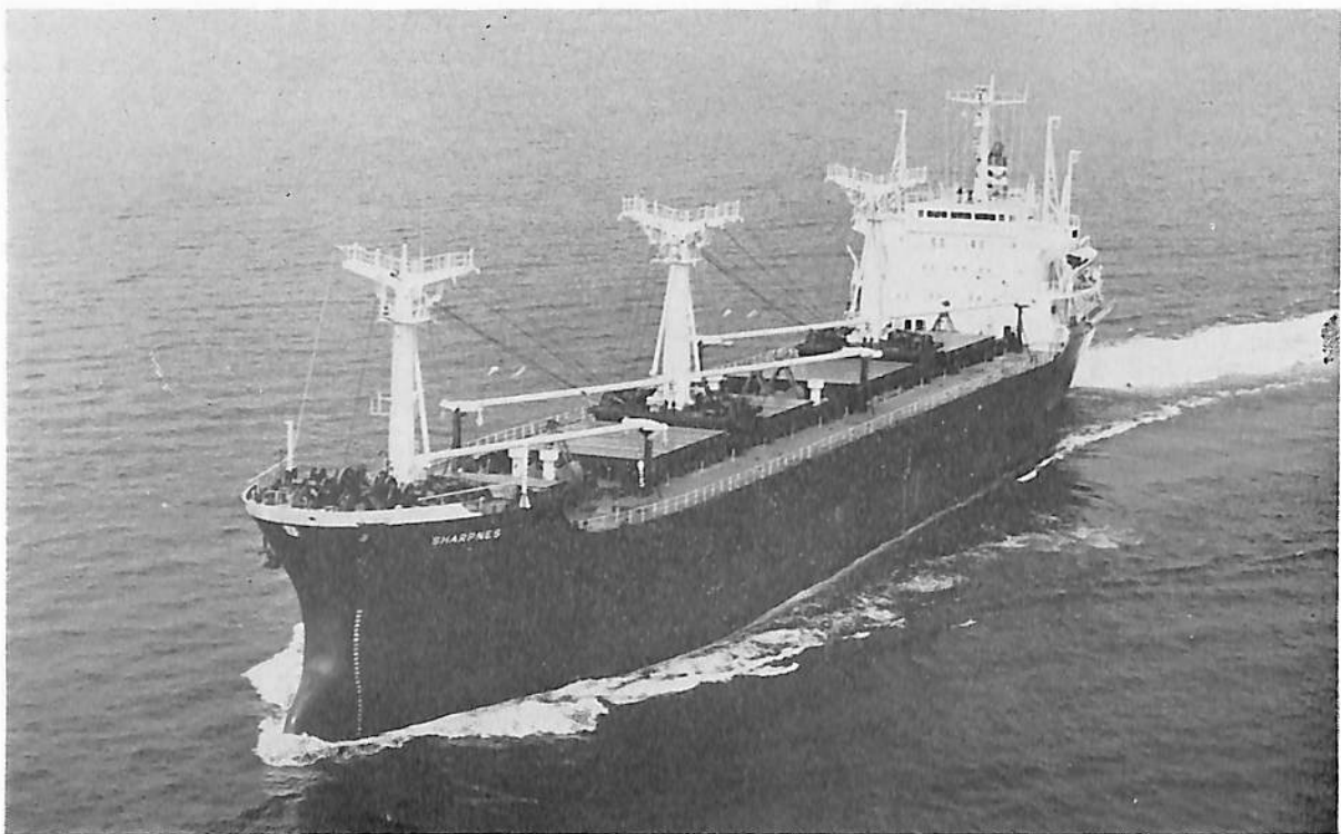
SHARPNES (ばら積貨物船) 船主 Kristian Jebsen (U.K) Ltd. (イギリス) 造船所 日本鋼管・清水造船所 総噸数 12,932.17 噸 純噸数 8,015.31 噸 遠洋 船級 LR 載貨重量 21,916 噸 全長 155.517 m 長(垂) 145.70 m 幅(型) 22.86 m 深(型) 13.40 m 吃水 9.839 m 満載排水量 26,684 噸 凹甲板型 主機 NKK-SEMΓ-ピールスチック 18 PC 2-2 V 400 型ディーゼル機関 1 基 出力 8,100 PS×500/126 RPM 燃料消費量 152.2 g/hp/h 航続距離 13,100 海里 速力 14.8 ノット 汽罐 コンポジット罐 発電機 3×350 KW, AC 437.5 V 貨物倉(ベール) 26,892.1 m 3 (グリーン) 25,852.1 m 3 燃料油倉 1,402.4 m 3 清水倉 125.0 m 3 乗員 29 名(外 3 名) 工期 47-11-25, 48-2-26, 48-5-25 同型船 SWIFTNES, SALTNES, SPRAYNES, SEALNES
