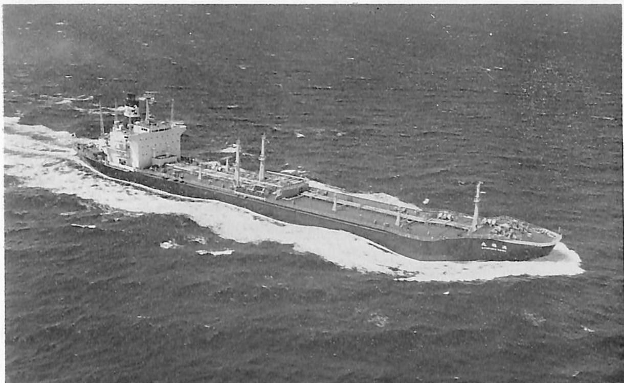
流 福 丸 (油 槽 船) 船 主 流 通 海 運 株 式 会 社 造 船 所 常 石 造 船 株 式 会 社 総噸数 20,859.69 噸 純噸数 12,850.51 噸 遠洋 船級 NK 載貨重量 36,474 噸 全長 189.00 m 長(垂) 180.00 m 幅(型) 27.00 m 深(型) 14.95 m 吃水 11.024 m 満載排水量 45,141 噸 船首楼付平甲板型 主機 三井 B&W 6 K 84 EF 型ディーゼル機関 1 基 出力 13,200 PS×108 RPM 燃料消費量 50.1 t/d 航続距離 約 11,700 海里 速力 15.7 ノット 汽罐 32 T/H×16 kg/cm 2 G 発電機 610 KW×2 貨油倉 44,606.5 m 3 燃料油倉 F.O 1,746.0 m 3 D.O 225.6 m 3 清水倉 277.5 m 3 乗員 27 名(含スペア 4) 工期 47-7-7, 47-11-12, 48-3-28
