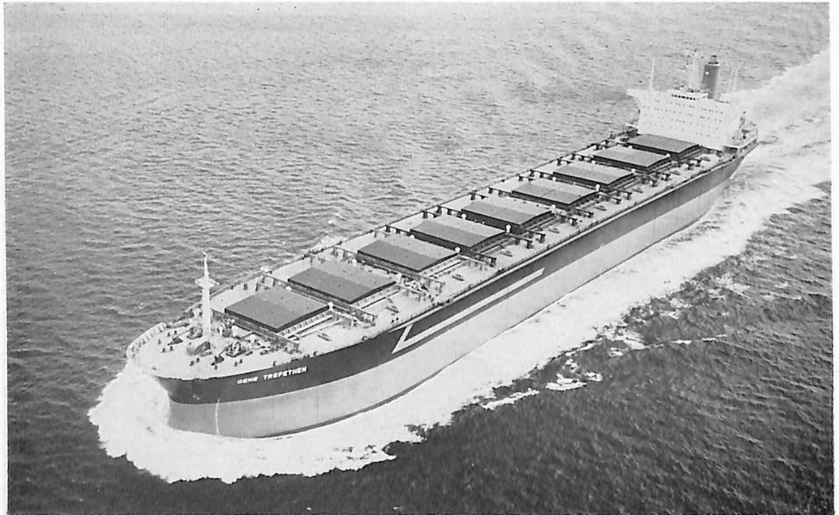
GENE TREFEIHEN (ばら積貨物船) 船主 United International Alumina Carriers Ltd. (リベリア) 造船所 三菱重工業・広島造船所 総噸数 59,192.71 噸 純噸数 45,340 噸 遠洋 船級 AB 載貨重量 127,588 噸 全長 261.0 m 長(垂) 247.0 m 幅(型) 40.6 m 深(型) 24.0 m 吃水 17.615 m 満載排水量 148,000 Lt 平甲板 型 主機 三菱スルザー 8 RND 90 型ディーゼル機関 1 基 出力 20,000 PS×116 RPM 燃料消費量 72 t/d 航続距 離 26,000 海里 速力 14.8 ノット 汽罐 コクラン缶×1 発電機 8 SH 24 AC 型×3 AC 450, 850 KVA 貨物倉 (グリーン) 141,174.6 m 3 燃料油倉 6,099.8 m 3 清水倉 698.0 m 3 乗員 47 名 (外 3 名) 工期 47-10-10, 48-2-10, 48-4-27
