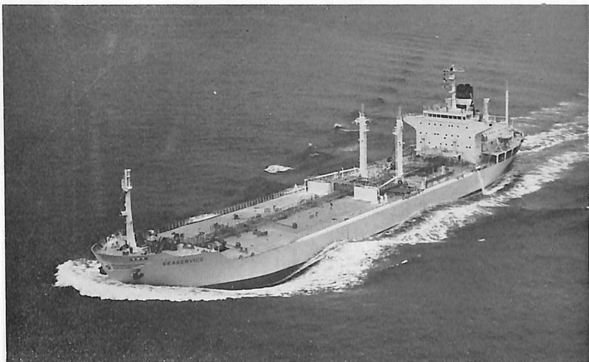
SEASERVICE (油槽船) 船主 Seaservice Tankers Inc. (リベリア) 造船所 株式会社 名和造船所 総噸数 15,027.38 噸 純噸数 9,933 噸 遠洋 船級 AB 載貨重量 30,169 噸 全長 171.02 m 長(垂) 162.00 m 幅(型) 25.40 m 深(型) 14.35 m 吃水 10.713 m 満載排水量 37,082 m 凹甲板船 主機 三菱スルザー7 RND 68 型ディーゼル機関 1 基 出力 9,820 PS×142 RPM 燃料消費量 37.6 t/d 航続距離 16,500 海里 速力 15.0 ノット 発電機 AC 700 KVA(560 KW)×450 V×2 台 貨油倉 34,050 m 3 燃料油倉 2,014.1 m 3 清水倉 254.8 m 3 乗員 40 名 工期 47-11-21, 48-2-20, 48-5-25
