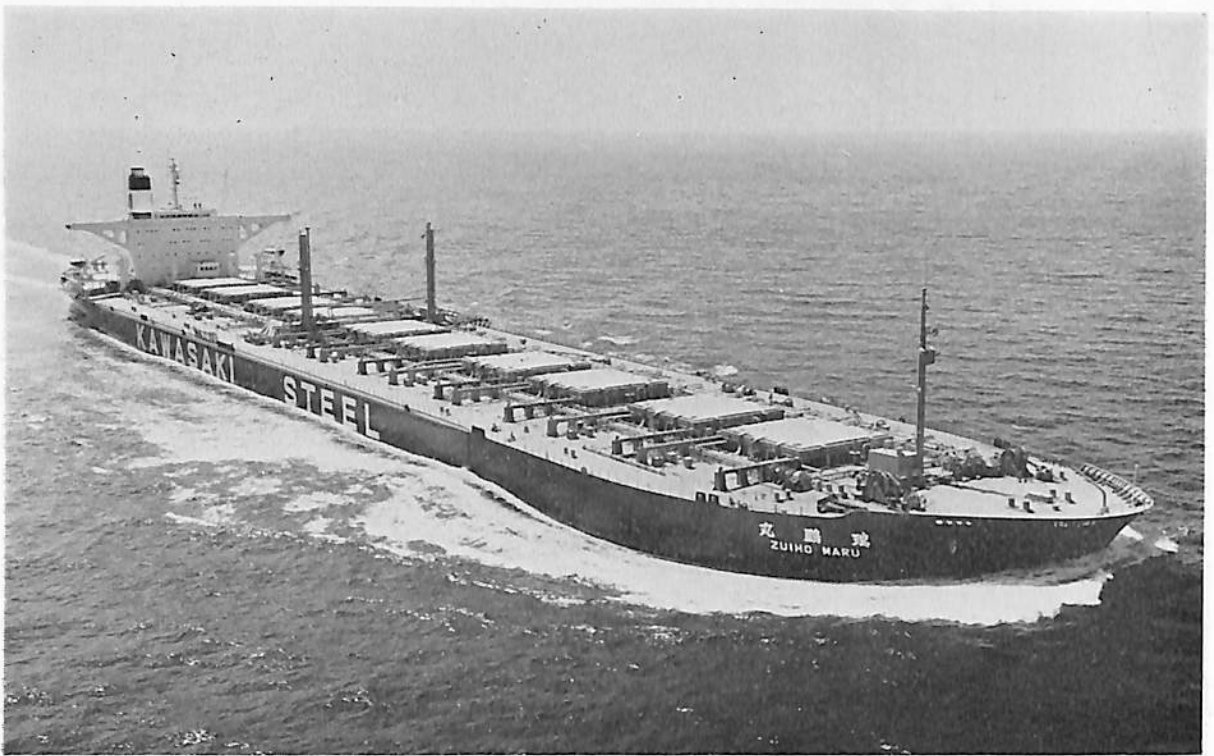
瑞 鴻 丸 (鉾石兼油槽船) 船主 山下新日本汽船株式会社, 日正汽船株式会社 造船所 日立造船 ・因島工場 総噸数 89,504.33 噸 純噸数 62,707.83 噸 遠洋 船級 NK 載貨重量 164,970 噸 全長 300.0 m 長(垂) 289.0 m 幅(型) 48.0 m 深(型) 23.0 m 吃水 17.62 m 満載排水量 196,527 噸 平甲板船 主機 日立 B&W 12 K 84 EF 180 型ディーゼル機関 1 基 出力 26,950 PS×108 RPM 燃料消費量 101.8 t/d 航続距離 26,500 海里 速力 15.5 ノット 汽缶 三胴水管ボイラ×1 発電機 タービン 1250 KVA×1 ディーゼル 1225 KVA×1 貨物倉 92,814.14 m 3 貨油倉 198,477.16 m 3 燃料油倉 7,839.39 m 3 清水倉 1,060.72 m 3 乗員 40 名 工期 47-9-29, 48-2-29, 48-4-27
