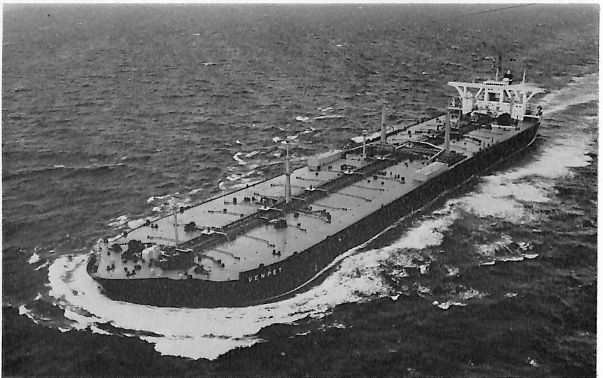
VENPET (油槽船) 船主 Venpet Inc. (リベリア) 造船所 三菱重工業・長崎造船所 総噸数 152,372.15 噸 純噸数 130,774 噸 遠洋 船級 AB 載貨重量 325,645 噸 全長 340.00 m 長(垂) 322.00 m 幅(型) 53.60 m 深(型) 32.00 m 吃水 80'-11 1 / 2 " 平甲板船 主機 三菱 2 段減速装置付タービン 1 基 出力 36,000 PS×90 RPM 燃料消費量 174 t/d 航続距離 30,000 海里 速力 15.0 ノット 汽罐 三菱 CE-V 2 M-8 W 型×2 發電機 AC 450 V×1,400 KW×1 貨油倉 396,028.8 m 3 燃料油倉 16,750.7 m 3 清水倉 474.8 m 3 乗員 41 名 (外 11 名) 工期 47-9-21, 48-1-14, 48-6-12 設備 AB の "ACCU" (機関部無人化)
