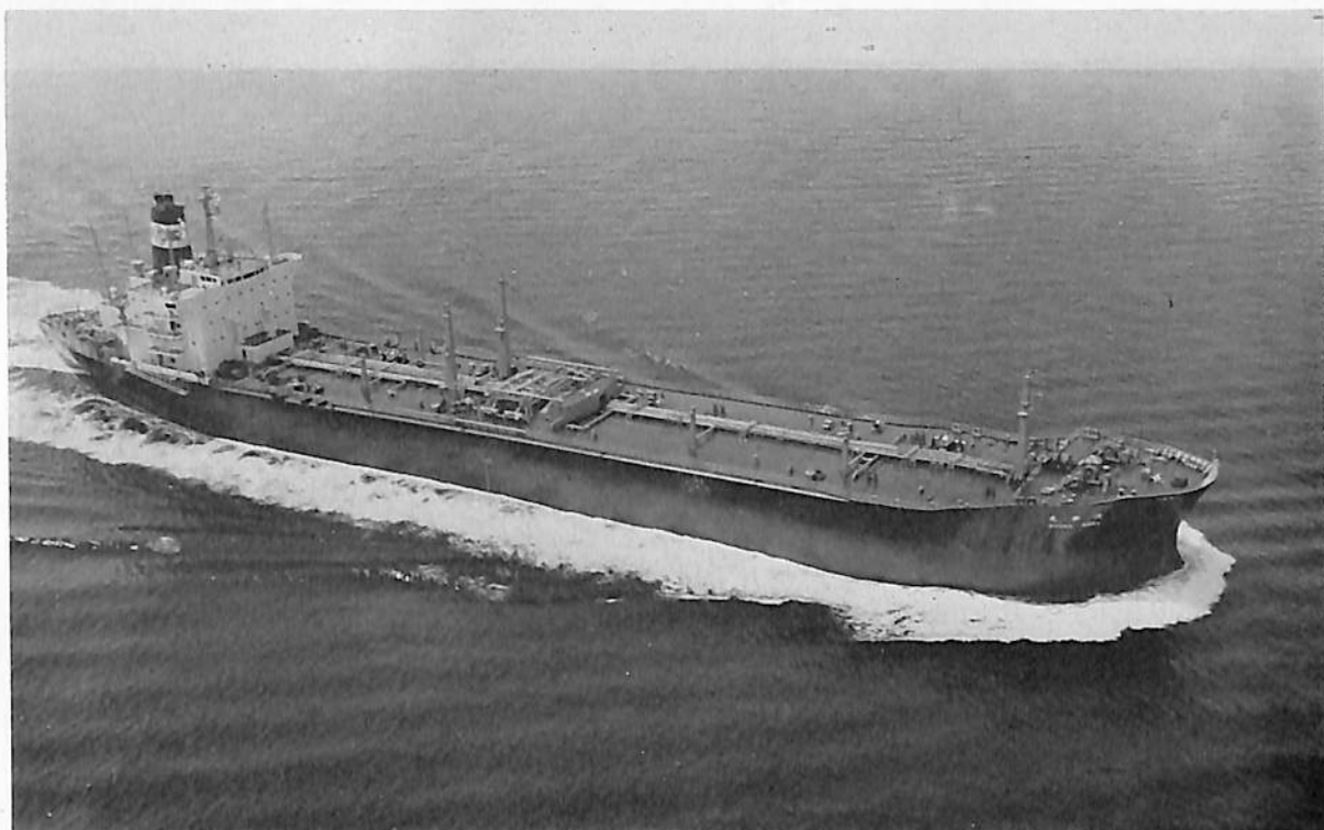
流興丸(油槽船) 船主 流通海運株式会社 造船所 常石造船株式会社 総噸数 20,853.46 噸 純噸数 12,856.16 噸 遠洋 船級 NK 載貨重量 36,573 噸 全長 189.00 m 長(垂) 180.00 m 幅(型) 27.00 m 深(型) 14.95 m 吃水 11.00 m 満載排水量 45,141 噸 船首樓付平甲板型 主機 三井 B&W 6 K 84 EF 型ディーゼル機関 1 基 出力 13,200 PS×108 RPM 燃料消費量 約 50.1 t/d 航続距離 11,700 海里 速力 15.6 ノット 発電機 920 PS×2 貨油倉 44,606.5 m 3 燃料油倉 1,786.8 m 3 清水倉 404.5 m 3 乗員 26 名 工期 47-10-27, 48-1-18, 48-5-24
