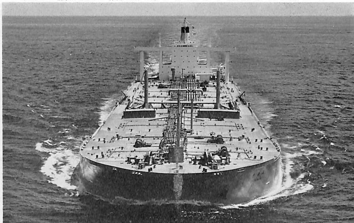
清 和 丸 (油 槽 船) 船 主 昭 和 海 運 株 式 会 社 造 船 所 川 崎 重 工 業 ・ 坂 出 工 場 総 噸 数 115,206.70 噸 純 噸 数 90,295.70 噸 遠 洋 船 級 NK 載 貨 重 量 231,439 噸 全 長 319.30 m 長 (垂) 305.00 m 幅 (型) 53.00 m 深 (型) 25.30 m 吃 水 19.5365 m 滿 載 排 水 量 266,205 噸 船 首 樓 付 平 甲 板 型 主 機 川 崎 UA -360 型 ター ビ ン 1 基 出 力 35,000 PS × 89 RPM 燃 料 消 費 量 173.7 t/d 航 続 距 離 17,560 海 里 速 力 16.56 ノ ッ ト 汽 缸 川 崎 UMG 72/56 × 2 燃 料 油 倉 8,551.95 m 3 清 水 倉 607.57 m 3 旅 客 2 名 乗 員 33 名 工 期 47- 10-6, 48-2-14, 48-5-24
