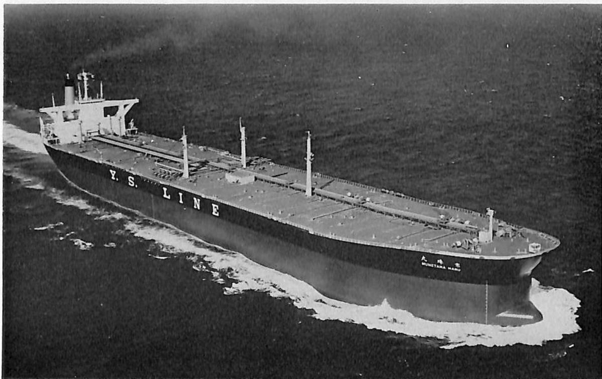
宗 珠 丸 (油槽船) 船主 山下新日本汽船株式会社 造船所 佐世保重工業・佐世保造船所 全長 341.10 m 長(長) 324.00 m 幅(型) 53.50 m 深(型) 25.70 m 吃水 20.00 m 総噸数 128,837.25 噸 載貨重量 258,096 噸 速力(試) 16.27 ノット (航) 15.35 ノット 主機 三菱タービン 1 基 出力(連続最大) 36,000 PS 船級 NK 工期 47-12, 48-3, 48-7-3 M0 船, イナートガス発生装置, 揚錨機係船機とも機側および両舷側の遠隔操作, 錨鎖の急速落下防止用油圧式スピードコントローラー装備
