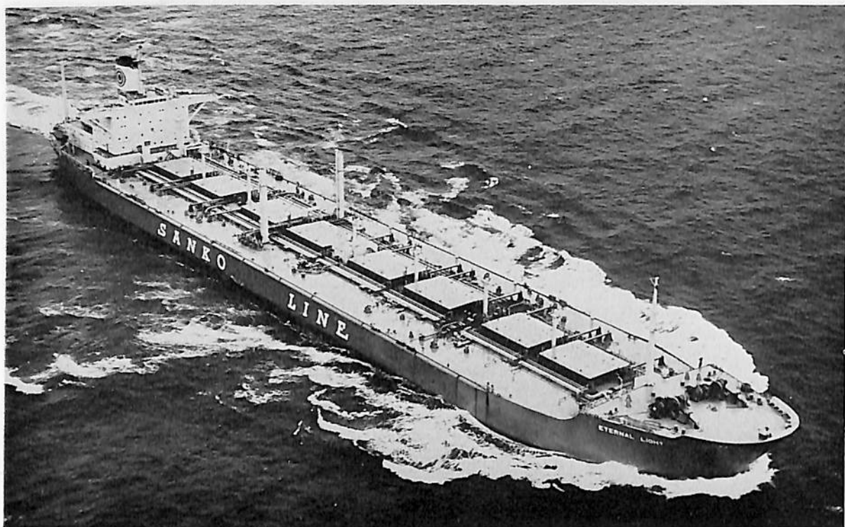
ETERNAL LIGHT (転石兼油槽船) 船主 Eternal Marine Corporation (リベリア) 造船所 三菱重工業・横浜造船所 総噸数 45,500.48 噸 純噸数 28,102.98 噸 遠洋 船級 NK 載貨重量 76,782 噸 全長 237.70 m 長(垂) 226.00 m 幅(型) 36.00 m 深(型) 19.10 m 吃水 13.402 m 平甲板船 主機 三菱スルザー7RND 90 型 ディーゼル機関 1 基 出力 18,270 PS×118 RPM 燃料消費量 67.1 t/d 汽缸 三菱 CE 2 胴管式 16 kg/cm 2 g, 38 0 t/h×1 貨物倉(グレーン) 40,648 m 3 貨油倉 93,373 m 3 燃料油倉 5,638.00 m 3 清水倉 456.00 m 3 乗員 37 名 工期 47-9-21, 48-1-26, 48-5-15 同型船 こーかさす丸 設備 イナートガスシステム
