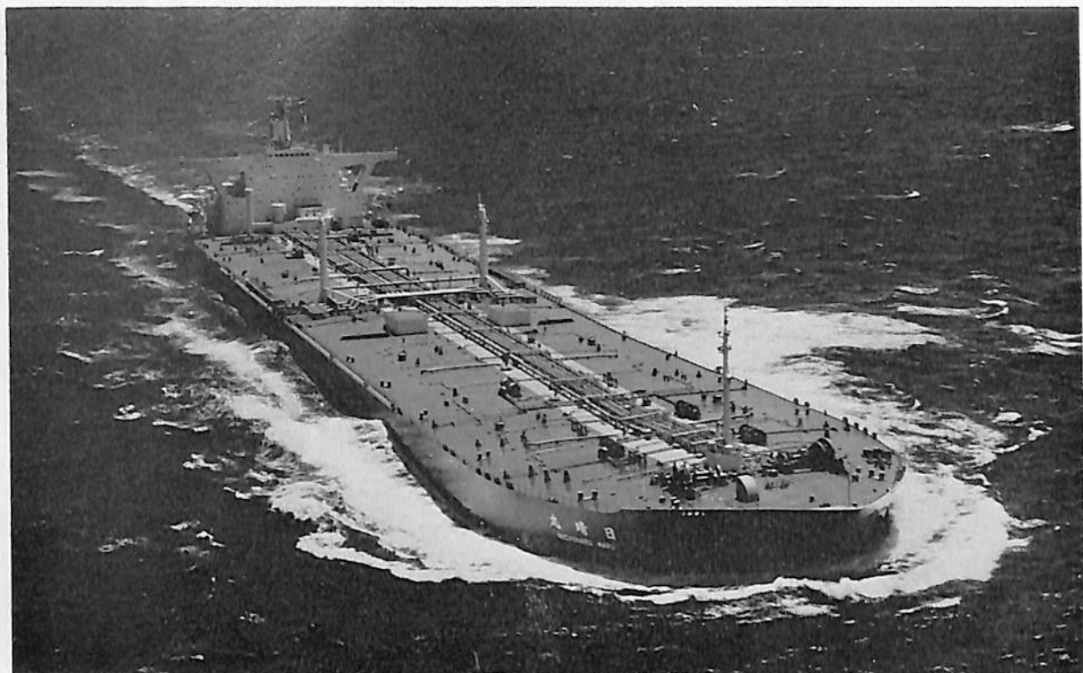
日 晴 丸 (油 槽 船) 船 主 山 下 新 日 本 汽 船, 日 正 汽 船, 雄 洋 海 運 ・ 株 式 会 社 造 船 所 日 立 造 船 ・ 堺 工 場 総 噸 数 120,704.16 噸 純 噸 数 90,247.23 噸 遠 洋 船 級 NK 載 貨 重 量 237,586 噸 全 長 324.00 m 長 (垂) 310.00 m 幅 (型) 53.00 m 深 (型) 25.00 m 吃 水 19.42 m 滿 載 排 水 量 272,088 噸 一 層 甲 板 型 主 機 日 立 船 用 ター ビ ン UA-360 型 1 基 出 力 35,000 PS × 89 RPM 燃 料 消 費 量 173.1 t/d 航 続 距 離 15,850 海 里 速 力 15.7 ノ ッ ト 汽 缸 日 立 BD 75/55 US 型 × 2 発 電 機 150 KW × AC 450 V × 2 貨 油 倉 282,663.5 m 3 燃 料 油 倉 7,718.2 m 3 清 水 倉 335.0 m 3 乗 員 40 名 工 期 47-9-27, 48-2-24, 48-5-30 M0 船
