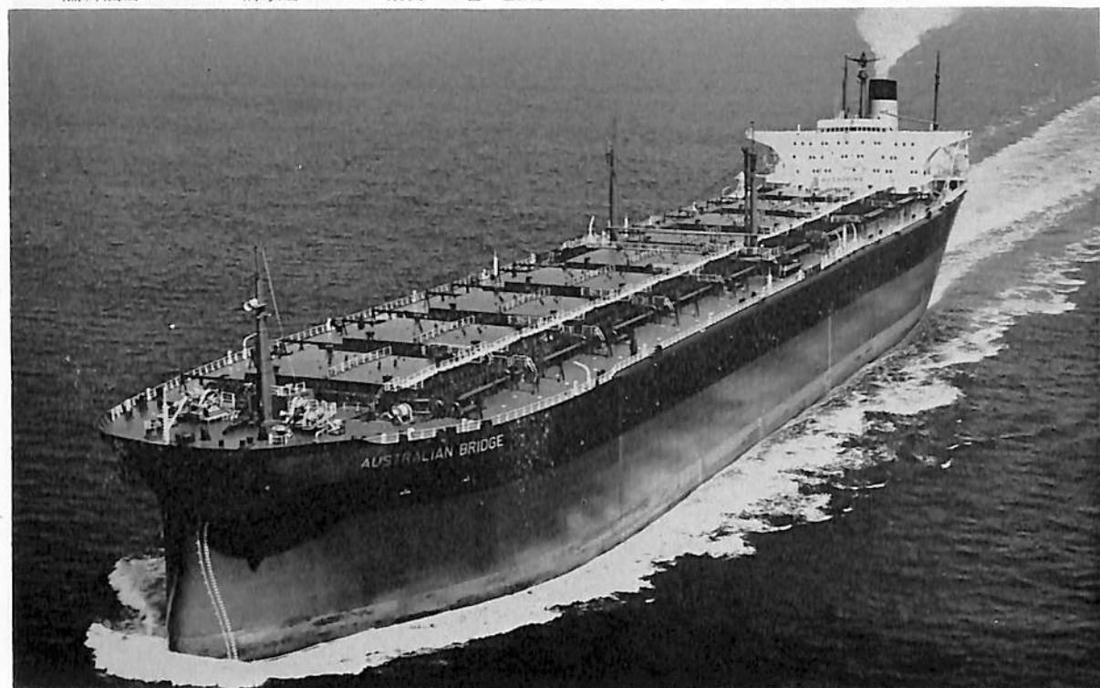
AUSTRALIAN BRIDGE (鉱石, はら, 油槽船) 船主 Bibby Line Ltd. (イギリス) 造船所 住友重機械工業 浦賀造船所 総噸数 79,256.51 噸 純噸数 57,081.49 噸 遠洋 船級 LR 載貨重量 145,015 噸 全長 266.00 m 長(垂) 258.00 m 幅(型) 44.00 m 深(型) 24.50 m 吃水 18.069 m 満載排水量 171,479 噸 平甲板型 主機 住友スルザー 10 RND 90 型ディーゼル機関 1 基 出力 24,650 PS×116 RPM 燃料消費量 89.5 t/d 航続距離 24,000 海里 速力 16.08 ノット 汽罐 水罐式×2 発電機 850 KW, AC 450V×3 貨物倉(グリーン) 151,511 m 3 貨油倉 165,223 m 3 燃料油倉 6,670 m 3 清水倉 607 m 3 乗員 51 名 工期 47-9-8, 48-1-6, 48-4-27
