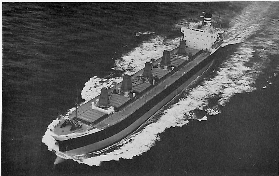
WANDERER (ばら積貨物船) 船主 The Charente Steam-Ship Co. Ltd (イギリス) 造船所 日本鋼管・清水造船所 総噸数 16,317.14 噸 純噸数 10,482.08 噸 遠洋 船級 LR 載貨重量 27,565 噸 全長 174.092 m 長(垂) 164.592 m 幅(型) 22.86 m 深(型) 14.707 m 吃水 10.977 m 満載排水量 34,104 噸 凹型甲板船 主機 住友スルザー 6 RND 76 型ディーゼル機関 1 基 出力 10,800 PS×118 RPM 燃料消費量 42.2 t/d 航続距離 14,800 海里 速力 15.2 ノット 汽罐 立型煙管式 発電機 420 KW, AC 450 V×3 貨物倉(ベール) 29,398.1 m 3 (グレーン) 36,117.8 m 3 燃料油倉 2,113.5 m 3 清水倉 208.7 m 3 乗員 36 名(外 2 名) 工期 48-1-16, 48-4-6, 48-6-22 同型船 WAYFARER
