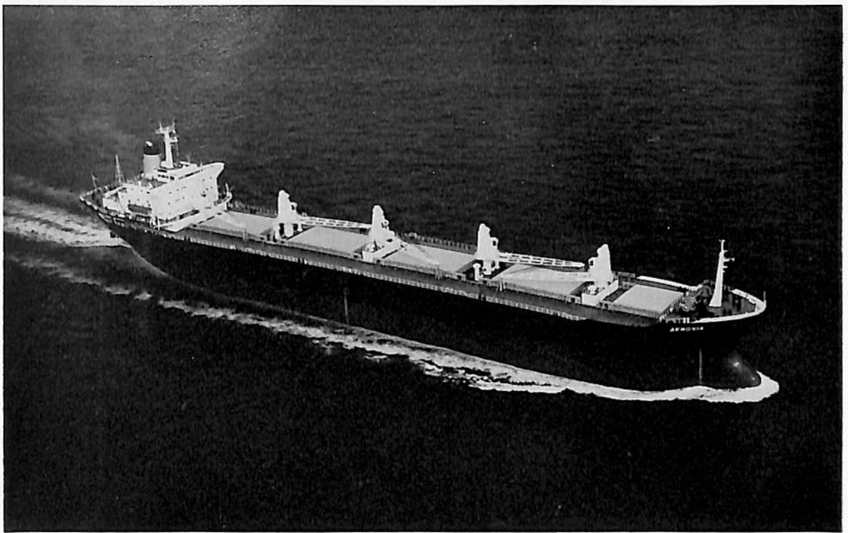
ARMONIA (ばら積貨物船) 船主 Harmisphere Navigation Corp. (リベリア) 造船所 佐野安船渠株式会社 総噸数 23,144.96 噸 遠洋 船級 AB 載貨重量 40,404 噸 全長 183.67m 長(垂) 173.00m 幅(型) 27.60m 深(型) 17.00m 吃水 12.107m 凹甲板型 主機 住友スルザー 7RND 76 型ディーゼル機関 1 基 出力 14,000 PS×122 RPM 航続距離 13,500 海里 速力 約 15.1ノット 汽罐 コクラン型 7kg/cm 2 ×1 発電機 AC 525 K VA×450 V×3 貨物倉(ペール) 53,674.6 m 3 (グリーン) 44,949 m 3 乗員 41 名 工期 48-1-12, 48-3 -26, 48-6-14 佐野安 "40BC" 型標準船型 第 1 船
