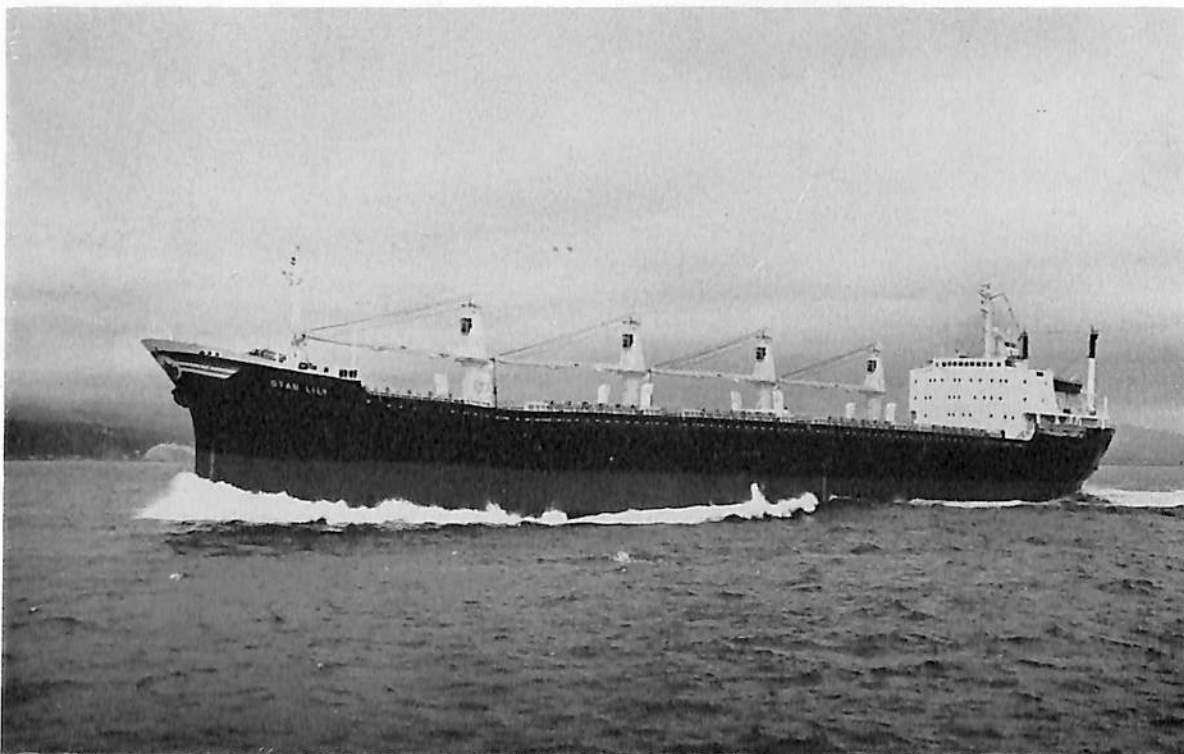
STAR LILY (ばら積貨物船) 船主 Hamilton Transport Company Inc (ギリシヤ) 造船所 函館ドック・函館造船所 総噸数 14,667.27 噸 純噸数 9,124.98 噸 遠洋 船級 LR 載貨重量 26,944 噸 全長 177.940 m 長(垂) 167.800 m 幅(型) 22.860 m 深(型) 14.710 m 吃水 10.689 m 満載排水量 33,269 噸 凹甲板船 主機 IHI-スルザー 6 RND 76 型ディーゼル機関 1 基 出力 10,800 PS×117.8 RPM 燃料消費量 40.8 t/d 航続距離 14,550 海里 速力 15.2 ノット 汽罐 1,200 kg/h×7 kg/cm 2 G×1 発電機 AC 550 KVA (440 KW)×3 貨物倉(ベール) 32,284 m 3 (グレーン) 32,639 m 3 燃料油倉 2,017 m 3 清水倉 282 m 3 乗員 48 名 工期 47-12-15, 48-3-13, 48-6-22
