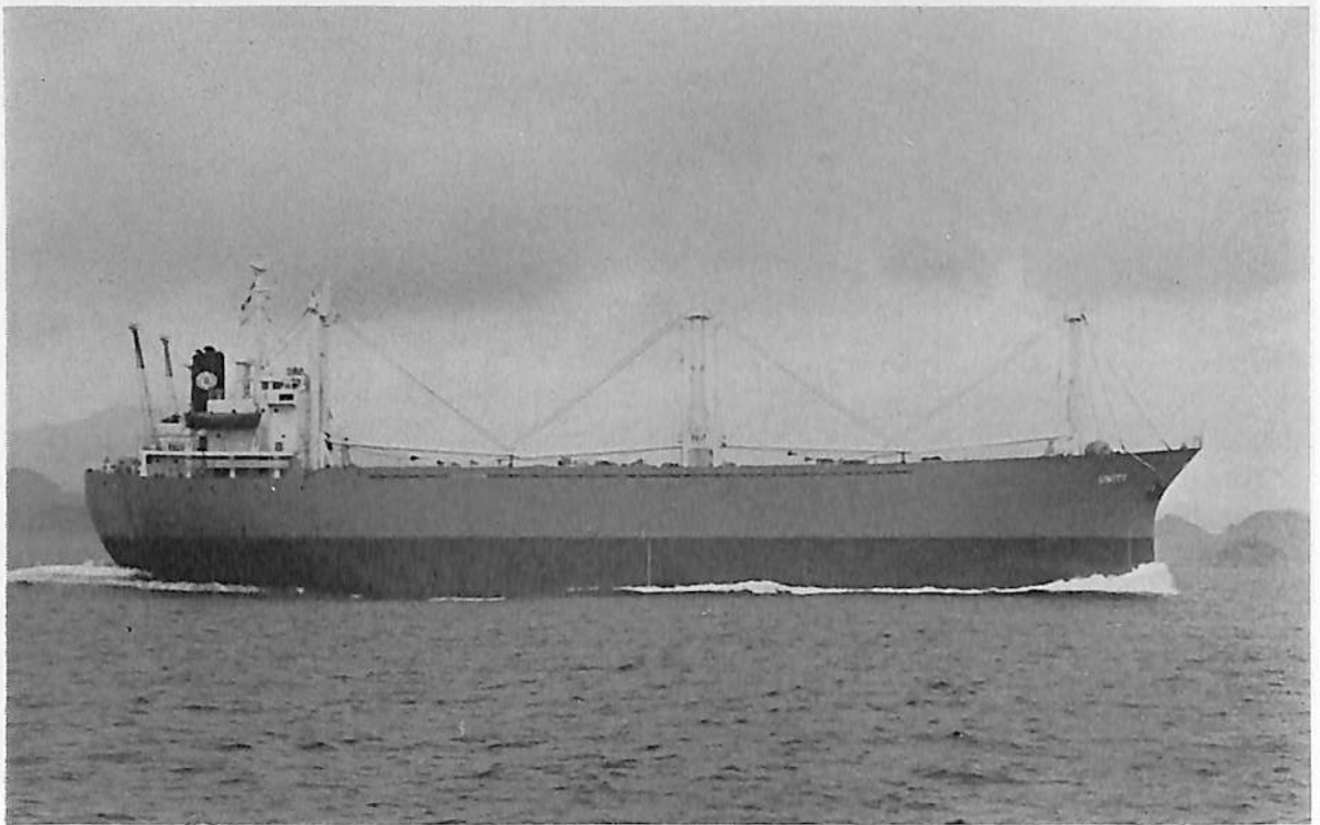
UNITY (貨物船) 船主 Universe Transportation Inc. (リベリア) 造船所 今治造船・今治工場 総噸数 3,713.43 噸 純噸数 2,148.81 噸 遠洋 船級 LR 載貨重量 7,623.87 噸 全長 108.00 m 長(垂) 98.00 m 幅(型) 17.20 m 深(型) 18.30 m 吃水 7.700 m 満載排水量 10,095.4 噸 全通甲板船 主機 阪神内燃機 6 LU 54 型ディーゼル機関 1 基 出力 3,825 PS×218 RPM 燃料消費量 14.94 t/d 航続距離 10,200 海里 速力 12.2 ノット 汽罐 70 kg/cm 2 800 kg/h×1 発電機 250 KVA×445 V×2 貨物倉(ペール) 13,520 m 3 (グリーン) 14,434 m 3 燃料油倉 632.82 m 3 清水倉 413.96 m 3 乗員 30 名 工期 47-12-18, 48-4-20, 48-6-8
