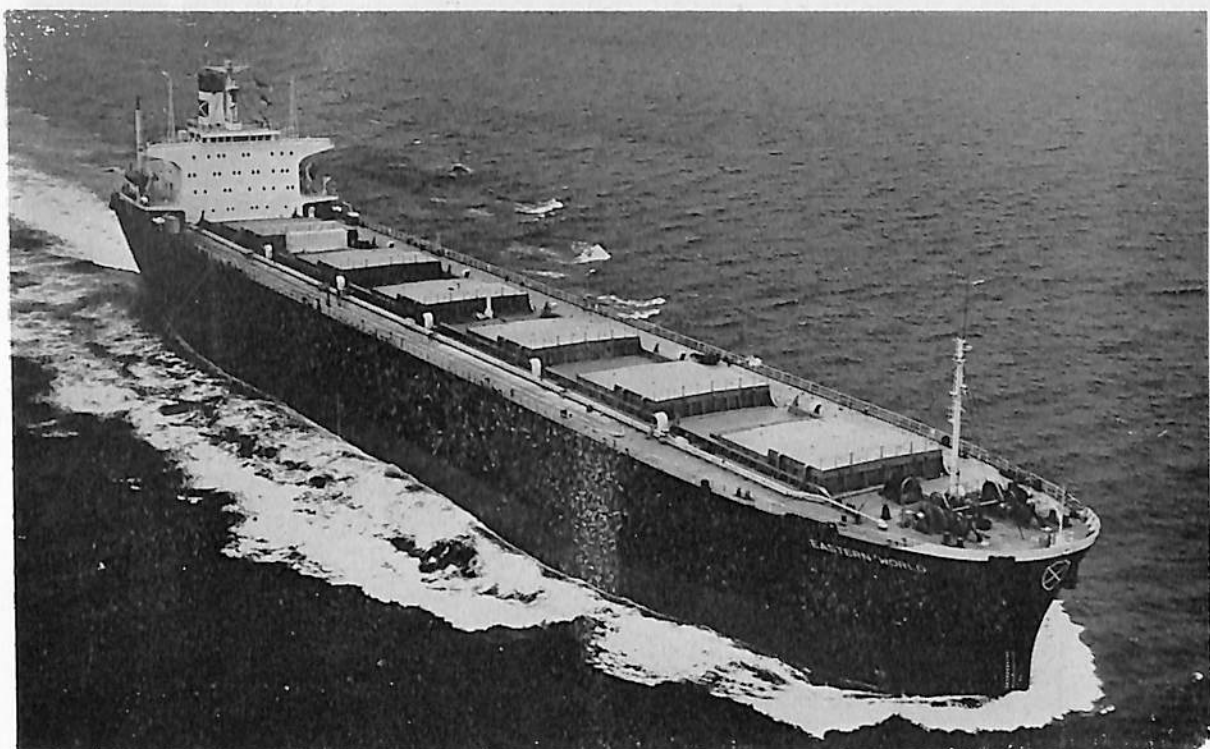
EASTERN WORLD (チップ運搬船) 船主 Eastern World Transpots Inc. (リベリア) 造船所 住友重機械工業・浦賀造船所 総噸数 31,903.61 噸 純噸数 23,141.36 噸 遠洋 船級 BV 載貨重量 37,911 噸 全長 193.00 m 長(垂) 188.00 m 幅(型) 29.40 m 深(型) 20.80 m 吃水 10.827 m 満載排水量 47,029 噸 平甲板型 主機 住友スルザー 6 RND 76 型ディーゼル機関 1 基 出力 10,200 PS×116 RPM 燃料消費量 35.4 t/d 航続距離 18,000 海里 速力 15.08 ノット 汽罐 1.2 t/h×1 台 発電機 580 KW×2 台 貨物倉(グリーン) 77,094 m 3 燃料油倉 1.783 m 3 清水倉 380 m 3 乗員 42 名 工期 47-11-17, 48-2-14, 48-5-18
