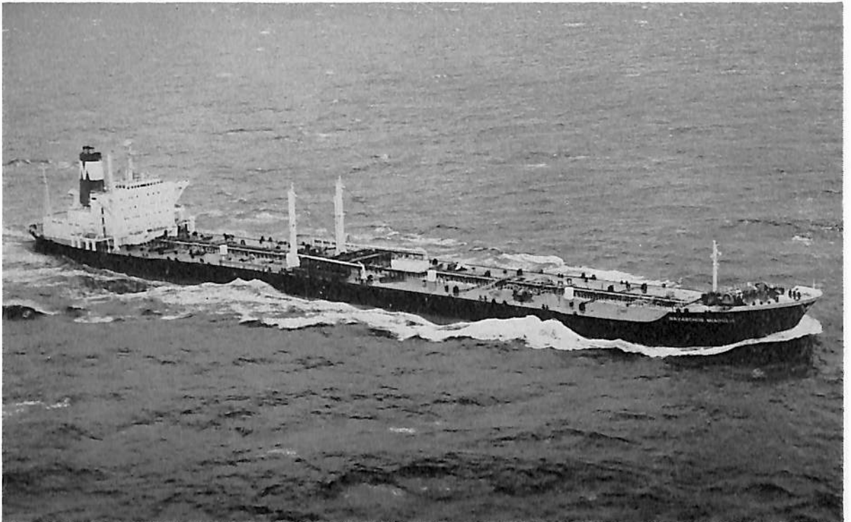
NAVARCHOS MIAOULIS (油槽船) 船主 Luna I Compania Naviera S.A. (パナマ) 造船所 日立造船・舞鶴工場 総噸数 35,339.5 噸 純噸数 26,112 噸 遠洋 船級 AB 載貨重量 71,204 噸 全長 239.293 m 長(垂) 228.00 m 幅(型) 33.70 m 深(型) 17.60 m 吃水 13.10 m 満載排水量 85,077 Lt 船首楼付一層甲板 船 主機 日立スルザー 6 RND 90 型ディーゼル機関 1 基 出力 15,600 PS×118 RPM 燃料消費量 61.23 t/d 速力 15.2 ノット 汽罐 日立 HZA-30 型×2 発電機 720 KW, AC 450 V×2 貨油倉 3,104.326 ft 3 燃料油倉 124,790 ft 3 清水倉 15,150 ft 3 乗員 38 名 工期 47-12-11, 48-3-6, 48-6-7
