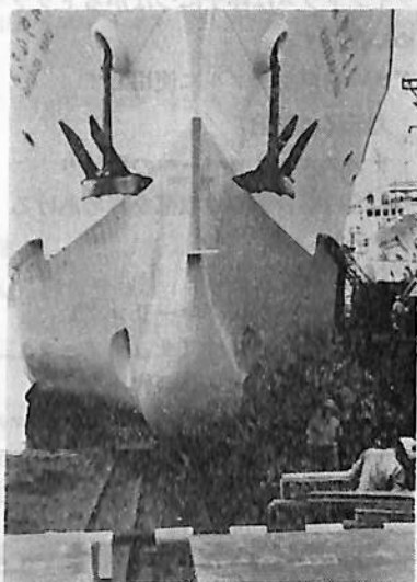
はやぶさ丸 船首 バルバスバウとパウスラスター開孔
