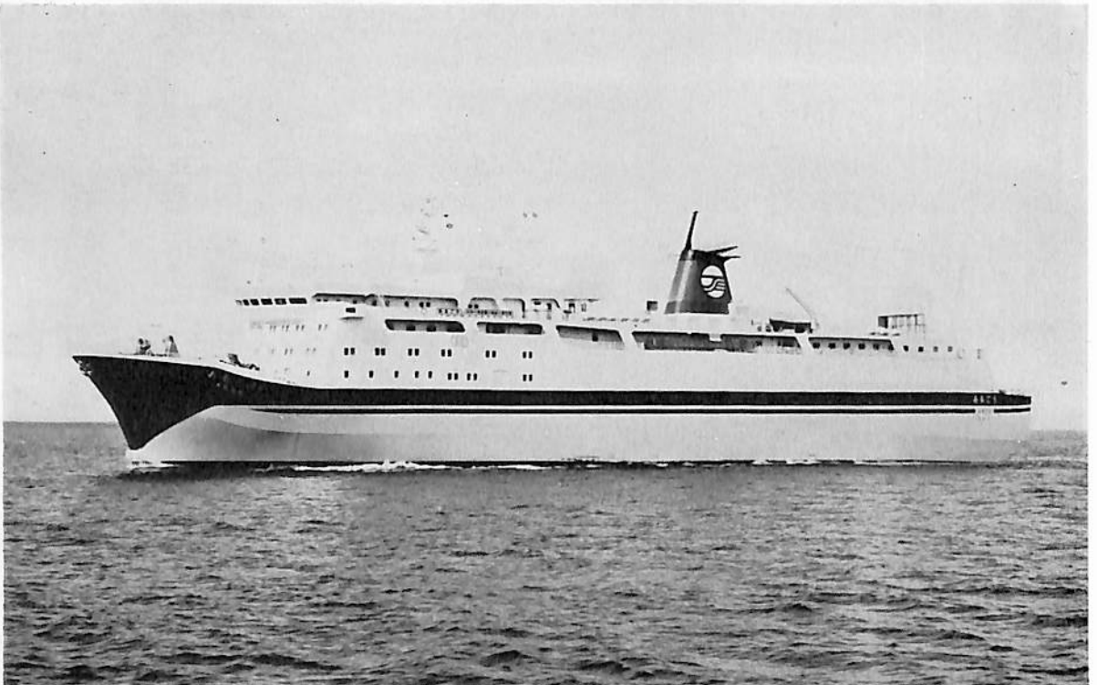
あるこう (自動車航送客船) 船主 太平洋沿海フェリー株式会社 造船所 三井造船株式会社, 日本海 重工業株式会社 総噸数 6,949.18 噸 純噸数 2,469.20 噸 近海 船級 JG 載貨重量 2,443 噸 全長 132.10 m 長(垂) 118.00 m 幅(型) 21.60 m 深(型) 8.00 m 吃水 5.50 m 満載排水量 7,691 噸 全通船楼船 主機 IHI 4 サイクル単動過給機付非逆転式トランクピストン歯車減速式ディーゼル機関 1 基 出力 7,200 PS×502.1 RPM 燃料消費量 52.6 t/d 航続距離 1,800 海里 速力 19.5 ノット 汽罐 2,100 kg/h, 7 kg/cm 2 G 1 台 発電機 640 KW×3 台 貨物倉(ベール) 12,851 m 3 旅客定員 699 名 トラック積載量 (8 t トラック換算) 88 台 乗用車 94 台 燃料油倉 282.9 m 3 清水倉 448.1 m 2 乗員 73 名 工期 47-12-14, 48-3-20, 48-6-25
