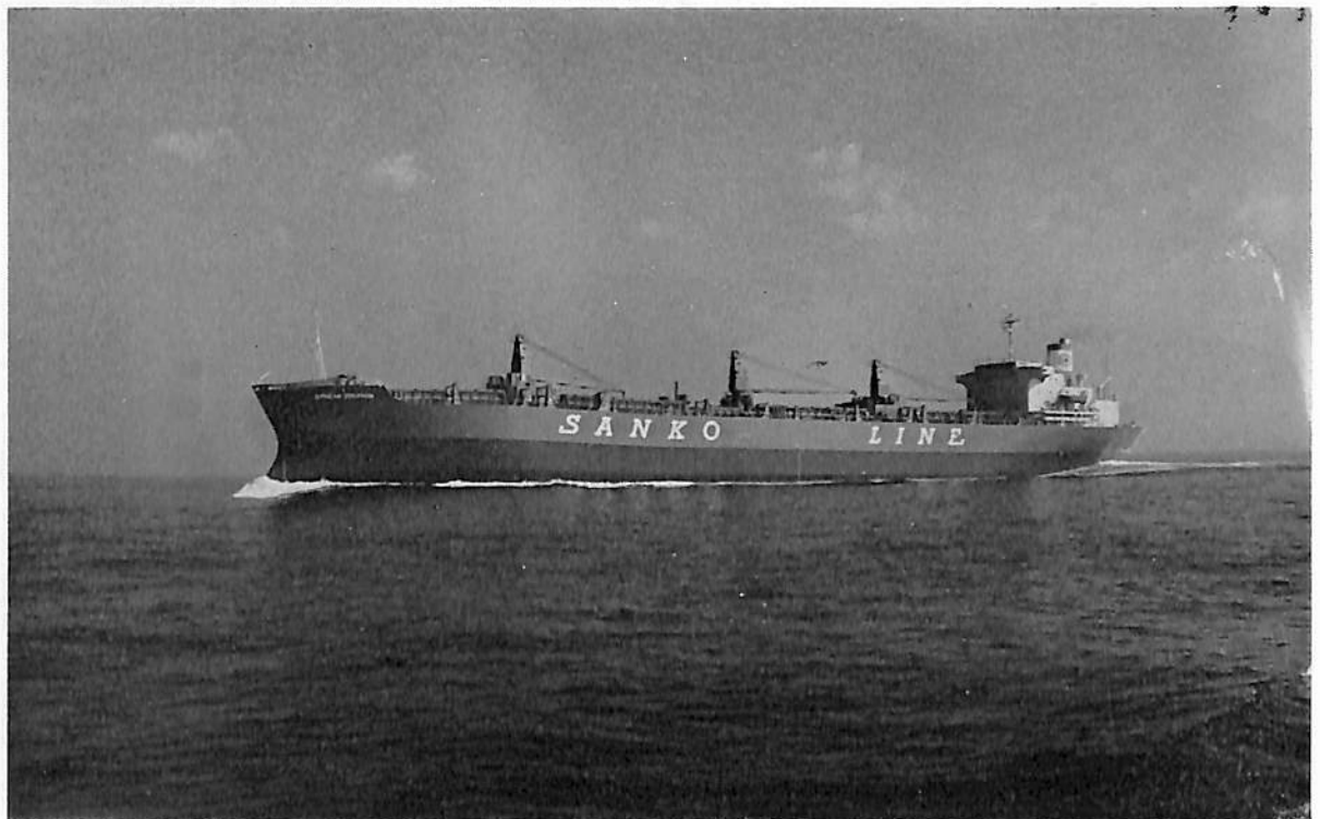
STREAM DOLPHIN (自動車兼ばら積貨物船) 船主 Dolphin Transport Corp. (リベリア) 造船所 株式会社 大阪造船所 総噸数 20,532.45 噸 純噸数 14,472 噸 遠洋 船級 AB 載貨重量 33,042 噸 全長 185.371m 長 (垂) 175.00m 幅(型) 26.00m 深(型) 16.10m 吃水 11.385m 満載排水量 42,732 噸 船首楼付平甲板船 主 機 IHI-スルザー 6RND 76型ディーゼル機関 1 基 出力 10,800 PS×117.8 RPM 燃料消費量 約 43.25 t/d 航続 距離 約 15,600 海里 速力 14.8 ノット 汽罐 コンポジットボイラー 7kg/cm 3 1 台 発電機 AC 450 V 500 KVA 3 台 貨物倉(ペール) 40,088 m 3 (グリーン) 41,396 m 3 燃料油倉 2,137.9 m 3 清水倉 465.4 m 3 乗員 38 名 工期 48-1-24, 48-4-10, 48-6-22
