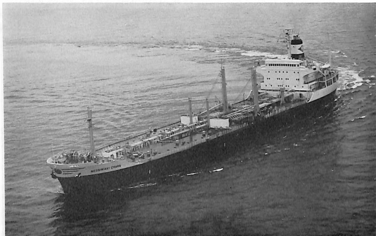
MESSINIAKI CHARA (油槽船) 船主 Calidad Navigacion, S.A. (ギリシヤ) 造船所 石川島播磨重工業 ・相生工場 総噸数 17,354.80 噸 純噸数 11,901.44 噸 遠洋 船級 LR 載貨重量 30,326 噸 全(長) 170.688 m 長(垂) 162.00 m 幅(型) 26.00 m 深(型) 14.35 m 吃水 11.006 m 凹甲板船 主機 IHI スルザー-7 RND 68 型ディーゼル機関 1 基 出力 10,400 PS×144.8 RPM 燃料消費量 37.2 t/d 航続距離 23,300 海里 速力 15.75 ノット 汽罐 水管式×2 発電機 420 KW×AC 60 Hz×450 V×3 貨油倉 37,941.5 m 3 燃料油倉 2,723.9 m 3 清水倉 481.00 m 3 乗員 41 名 工期 47-8-11, 47-11-10, 48-4-18
