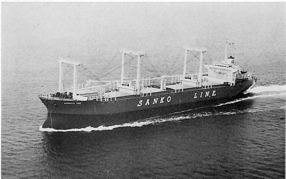
MAMMOTH PINE (木材兼ばら積貨物船) 主 船 Mammoth Bulk Carriers Limited (リベリア) 造船所 株式会社 金指造船所 総噸数 18,968.14 噸 純噸数 13,236.22 噸 遠洋 船級 BV 載貨重量 32,652 噸 全長 182.00m 長(垂) 170.00m 幅(型) 27.00 m 深(型) 15.20 m 吃水 10.823 m 満載排水量 40,731 噸 凹甲板型 主機 三井 B&W 6 K 74 EF 型ディーゼル機関 1 基 出力 10,600 PS×120RPM 燃料消費量 156 g/ps. h 航続距離 15,000 海里 速力 14.8ノット 汽罐 サンロット CPDB-15 型 発電機 AC 445 V×400 KW×3 貨物倉(ベール) 39,819 m 3 (グリーン) C.H. 41,476 m 3 T. S. T. 3,089 m 3 燃料油倉 A 211 m 3 C 2,066 m 3 清水倉 535 m 3 乗員 38 名 工期 47-11-9, 48-3-8, 48-7-5
