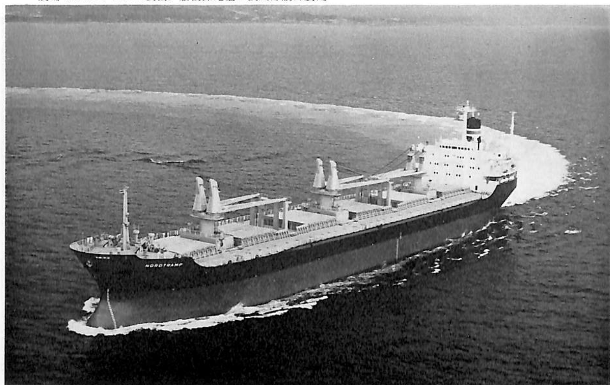
NORDTRAMP (ばら積貨物船) 船主 D/S Norden Ais (デンマーク) 造船所 三井造船・藤永田造船所 総噸数 19,624.62 噸 純噸数 13,539.94 噸 遠洋 船級 LR 載貨重量 34,288 噸 全長 179.00 m 長(垂) 170.00 m 幅(型) 27.00 m 深(型) 14.80 m 吃水 10.960 m 満載排水量 41,890 噸 凹甲板船 主機 三井 B&W 6 K 74 EF 型ディーゼル機関 1 基 出力 10,600 PS×120 RPM 燃料消費量 42.55 t/d 航続距離 14,200 海里 速力 15.0 ノット 汽罐 水管堅型ボイラー 発電機 750 BHP×3 貨物倉(ペール) 38,762 m 3 (グレーン) 44,131 m 3 燃料油倉 2,026.4 m 3 清水倉 419.9 m 3 乗員 34 名 工期 47-12-19, 48-4-3, 48-7-10
