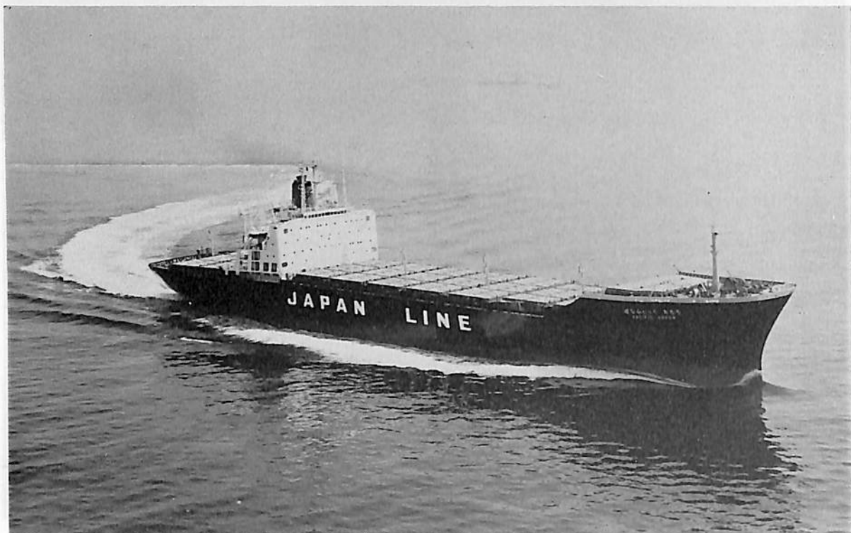
ばしふいっくあるう (コンテナ船) 船主 ジャパンライン株式会社 造船所 石川島播磨重工業・相生工場 総噸数 30,007.22 噸 純噸数 16,850.40 噸 遠洋 船級 NK 載貨重量 26,837 噸 全長 219.00 m 長(垂) 204.00 m 幅(型) 31.20 m 深(型) 18.90 m 吃水 11.2265 m 主機 IHI スルザー 9 RND 105 型ディーゼル機関 1 基 出力(最大) 36,000 PS×108 RPM (常用) 30,600 PS×102.3 RPM 燃料消費量 112.8 t/d 航続距離 18,300 海里 速力(試) 26.86 ノット(航) 22.8 ノット 発電機 1,000 KW×AC 60 Hz×450 V×3 コンテナ積載個 20' 505 個, 40' 468 個 燃料油倉 4,950.1 m 3 清水倉 550.2 m 3 乗員 34 名 工期 47-11-7, 48-1-6, 48-5-11
