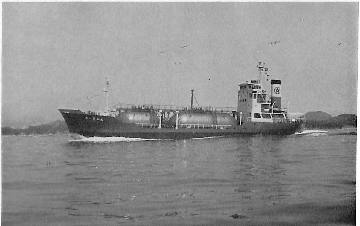
第一星和丸 (加圧式液化石油ガスタンク船) 船主 有限会社 星和海運 造船所 桧垣造船株式会社 総噸数 976.84 噸 純噸数 579.59 噸 船級 NK 載貨重量 861.8 噸 全長 62.400 m 長(垂) 56.100 m 幅 (型) 10.500 m 深(型) 4.800 m 吃水 4.212 m 満載排水量 1,712.5 噸 凹甲板船尾機関型 主機 阪神内燃機 6 LU 38 型ディーゼル機関 1 基 出力 1,785 PS×298 RPM 燃料消費量 8.904 t/d 航続距離 2,750 海里 速力 12.8 ノ ット 発電機 120 KVA×2 LPG タンク No.1 454.5 m 3 No.2 794.9 m 3 燃料油倉 79.653 m 3 清水倉 81,040 m 3 乗員 12 名 工期 48-3-14, 48-6-7, 48-7-14 設備 焼却炉 151/h×1
