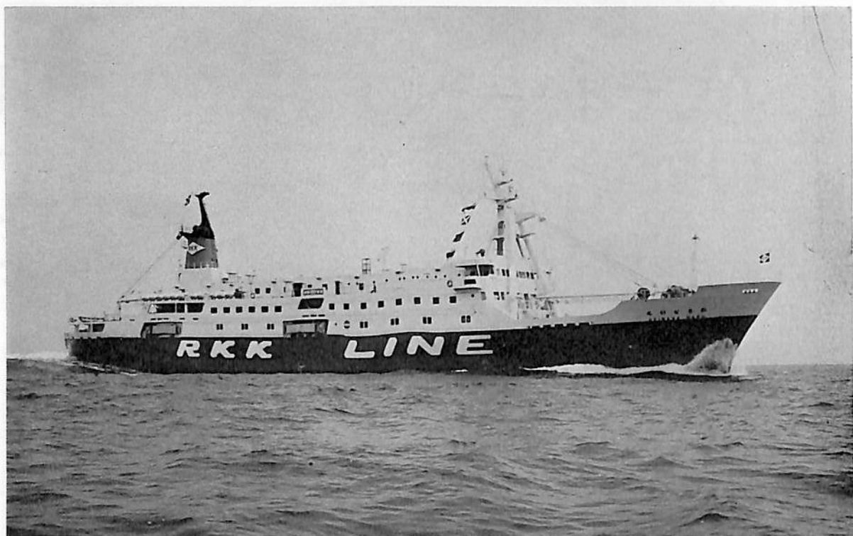
おきなわ丸(貨客船) 船主 琉球海運株式会社 造船所 尾道造船株式会社 総噸数 3,755.49 噸 純噸数 2,265.60 噸 近海 載貨重量 1,741.74 噸 全長 111.45 m 長(垂) 101.50 m 幅(型) 15.20 m 深(型) 8.90 m 吃水 5.416 m 満載排水量 4,362.88 噸 覆甲板船 主機 三菱 MAN V7 V 40/52 型ディーゼル機関 1 基 出力 6,840 PS×391/167 RPM 燃料消費量 24.5 t/d 航続距離 3,118.77 海里 速力 19.20 ノット 汽罐 クレイトン型 発電機 AC 525 KVA, DC 420 KW×450 V×3 貨物倉(ペール) 1,675.15 m 3 (グリーン) 1,723.20 m 3 旅客 1,031 名 燃料油倉 269.19 m 3 清水倉 403.62 m 3 乗員 44 名 工期 48-3-8, 48-6-1, 48-7-31
