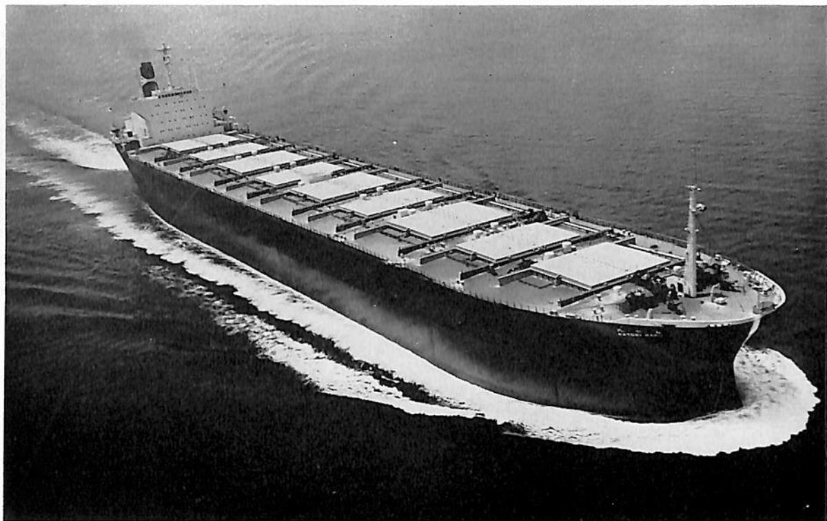
香 取 丸 (ばら積貨物船) 船主 第一中央汽船株式会社 造船所 住友重機械工業・浦賀造船所 総噸数 65,312.83 噸 純噸数 45,314.23 噸 遠洋 船級 NK 載貨重量 120,005 噸 全長 256.00 m 長(垂)244.00 m 幅(型) 40.20 m 深(型) 23.90 m 吃水 16.897 m 満載排水量 140,240 噸 平甲板船 主機 住友スルザー 8 RND 90 型ディーゼル機関 1 基 出力 19,700 PS×116 RPM 燃料消費量 71.0 t/d 航続距離 27,700 海里 速力 15.51 ノット 汽罐 重油専焼式 8.3 t/h (最大) 1 台 発電機 650 KW, 445 V×2 台 貨物倉(グリーン) 138,910 m 3 燃料油倉 6,169 m 3 清水倉 480 m 3 乗員 30 名 工期 48-1-8, 48-4-18, 48-7-16 設備 コンピューターを利用した自動航法システム採用 (詳細は本文 45 頁参照)
