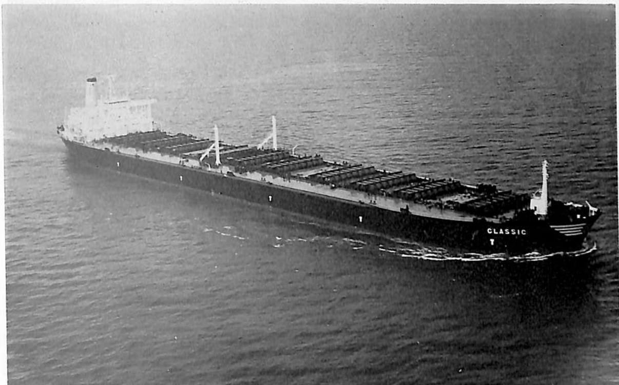
CLASSIC (ばら積兼油槽船) 船主 Fairwind Shipping Company S.A (ギリシヤ) 造船所 石川島播磨重工業・相生工場 総噸数 73,492.70 噸 純噸数 57,247 噸 遠洋 船級 AB 載貨重量 150,254 Lt 全長 291.00 m 長(垂) 278.80 m 幅(型) 44.50 m 深(型) 24.50 m 吃水 55'-10 3 / 8 " 平甲板型 主機 IHI 船用タービン 1 基 出力 24,000 PS × 80 RPM 燃料消費量 119.2 t/d 航続距離 20,500 海里 速力 15.7 ノット 汽罐 2 ドラム水管式 × 1 貨物倉(グレーン) 168,592.4 m 3 貨油倉 172,429.4 m 3 燃料油倉 7,414.7 m 3 清水倉 631.2 m 3 乗員 47 名 工期 47-10-16, 48-2-13, 48-6-8
