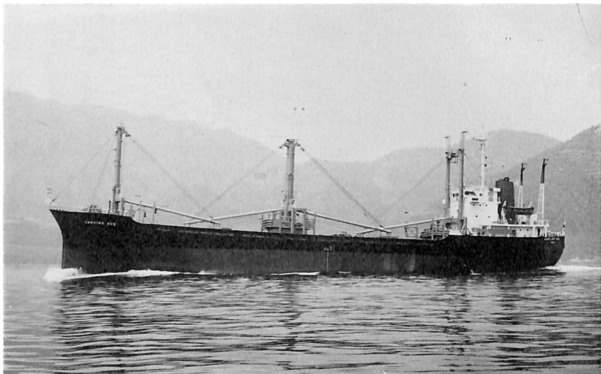
LASING ACE (貨物船) 船主 Lasing Corporation (パナマ) 造船所 波止浜造船株式会社 総噸数 4,446.83 噸 純噸数 2,892.18 噸 遠洋 船級 NK 載貨重量 7,292.29 噸 全長 110.00 m 長(垂) 101.90 m 幅(型) 17.50 m 深(型) 8.60 m 吃水 7.042 m 満載排水量 9,750.00 噸 凹甲板船尾機関型 主機 神戸発動 機 6 UET 15/80 D 型ディーゼル機関 1 基 出力 3,570 PS×218 RPM 燃料消費料 13.9 t/d 航続距離 12,800 海里 速力 12.70 ノット 汽鐘 コクランコンポジット型 600/450 kg/h 発電機 200 KVA×445 V×2 貨物倉(ベール) 8,836.47 m 3 (グリーン) 9,325.76 m 3 燃料油倉 794.20 m 3 清水倉 554.73 m 3 乗員 28 名 工期 48-3-5, 48-4-17, 48-6-27
