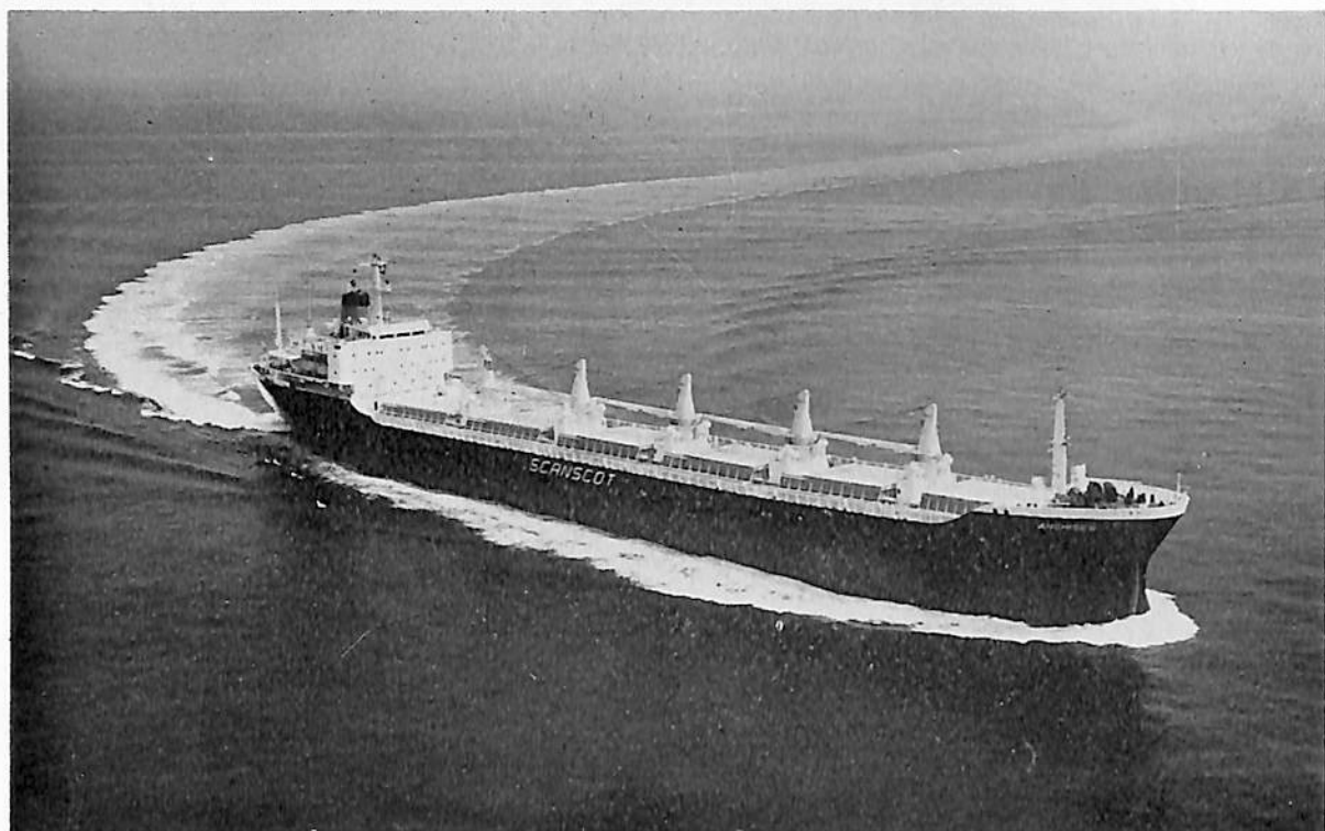
ANCHISES (ばら積貨物船) 船主 Ocean Titan Limited (英) 造船所 三井造船・藤永田造船所 総噸数 16,405.77 噸 純噸数 10,419.87 噸 遠洋 船級 AB 載貨重量 27,143 噸 全長 176.75m 長(垂)168.00 m 幅(型) 22.86 m 深(型) 14.10 m 吃水 10.566 m 満載排水量 33,864 噸 凹甲板船 主機 三井 B&W DE 6 K 74 EF 型ディーゼル機関 1 基 出力 10,600 PS×120 RPM 燃料消費量 42.55 t/d 航続距離 14,800 海里 速 力 15.25 ノット 汽罐 コンポジットボイラー(アールボルグ) 発電機 525 KVA×450 V×60 Hz×3 貨物倉 (ペール) 31,100 m 3 (グレーン) 36,224 m 3 燃料油倉 1,660.2 m 3 清水倉 287.5 m 3 乗員 39 名 工期 48— 3—2, 48—4—30, 48—7—31
