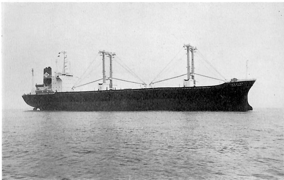
トランス ルビー (TRANS RUBY) (貨物船) 船主 徳島汽船株式会社, 日亜海運株式会社 造船所 株式会社新山本造船所 総噸数 14,969.99 噸 純噸数 9,568.90 噸 遠洋 船級 NK 載貨重量 22,868.20 噸 全長 154.08 m 長(垂) 142.00 m 幅(型) 23.60 m 深(型) 15.70 m 吃水 10.52 m 満載排水量 28,407 噸 船首楼付平甲板船 主機 三菱スルザー 7 RND 68 型ディーゼル機関 1 基 出力 10,395 PS×145 RPM 燃料消費量 41 t/d 航続距離 15,000 海里 速力 15.5 ノット 汽罐 コ克蘭コンポジット型 7 \text{ kg/cm}^2 発電機 450 KVA×445 V×2 貨物倉(ベール) 30,285 \text{m}^3 (グレーン) 31,972 \text{m}^3 燃料油倉 2,366.60 \text{m}^3 清水倉 1,107 \text{m}^2 乗員 34 名 工期 48-3-5, 48-5-16, 48-7-12
