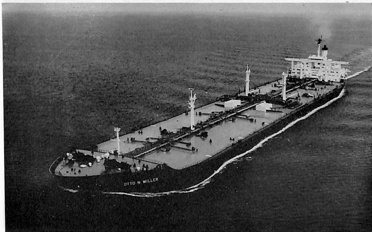
OTTO N. MILLER (油槽船) 船主 Chevron Transport Corp. (リベリア) 造船所 三菱重工業・長崎造船所 総噸数 118,197.11 噸 純噸数 100,269 噸 遠洋 船級 AB 載貨重量 264,197 噸 全長 338.629 m 長(垂) 320.00 m 幅(型) 53.60 m 深(型) 26.40 m 吃水 67'-5 3 / 8 " 船首樓付平甲板船 主機 三菱船用タービン 1 基 出力 34,000 PS×90 RPM 燃料消費量 165 t/d 航続距離 25,000 海里 速力 15.4 ノット 汽罐 三菱 CE-V 2M-8 W 型×2 貨油倉 320,552.1 m 3 燃料油倉 12,296.6 m 3 清水倉 372.5 m 3 乗員 51 名 (外 8 名) 工期 47-12- 11, 48-3-28, 48-7-25 同型船 PAUL L. FAHRNEY
