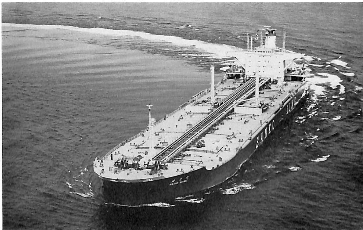
海 光 丸 (油槽船) 船主 三光汽船株式会社 造船所 川崎重工業・神戸工場 総噸数 71,764.99噸 純噸数 50,938.41噸 遠洋 船級 NK 載貨重量 139,698噸 全長 273.00 m 長(垂) 260.00 m 幅(型) 42.00 m 深(型) 17.00 m 吃水 17,861 m 満載排水量 163,624噸 船首樓付平甲板船 主機 川崎 MAN K 9 SZ 90/160 型ディーゼル機関 1 基 出力 23,500 PS \times 118 RPM 燃料消費量 88.5 t/d 航続距離 18,200 海里 速力 15.21 ノット 汽罐 1 \times 川崎 SM 72 2 胴水管式 発電機 1,450 KVA \times 2 燃料油倉 4,936 m 3 清水倉 217.7 m 3 乗員 40 名 工期 48-1-19, 48-4-3, 48-7-4
