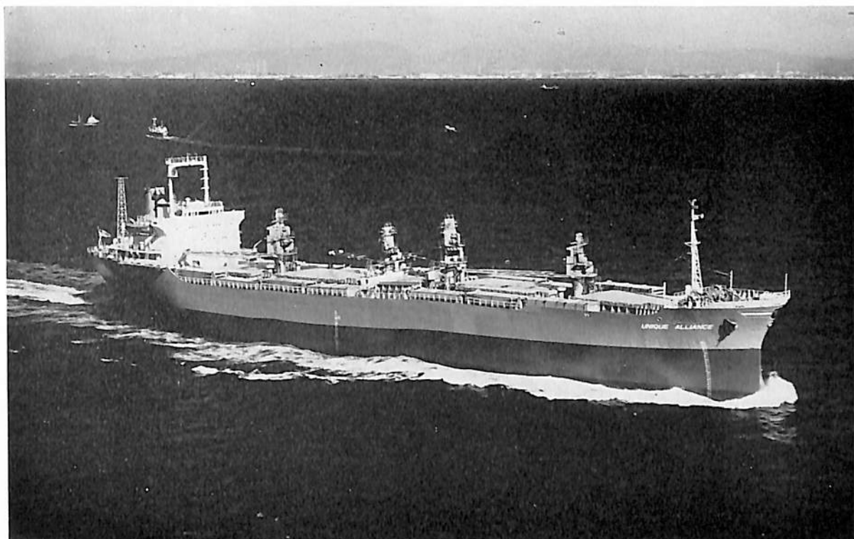
UNIQUE ALLIANCE (貨物船) 船主 Unique Development Company(リベリア) 造船所 佐野安船渠株式会社 総噸数 12,145.65 噸 遠洋 船級 AB 載貨重量 20,814 噸 全長 156.89 m 長(垂) 148.00 m 幅(型) 22.80 m 深(型) 13.50 m 吃水 9.88 m 凹甲板船 主機 三井 B&W 8 K 62 EF 型ディーゼル機関 1 基 出力(最大) 10,700 PS×144 RPM 航続距離 13,700 海里 速力 15.1 ノット 汽罐 コ克蘭型 7 \text{ kg/cm}^2 ×1 発電機 AC 400 KVA×450 V×3 貨物倉(ベール) 23,857 \text{m}^3 (グレーン) 27,209 \text{m}^3 自動車搭載数 552 台 乗員 42 名 工期 48-2-16, 48-5-14, 48-7-17
