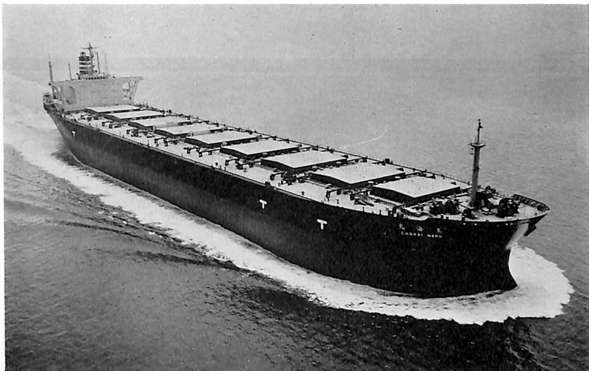
鳥海丸 (ばら積貨物船) 船主 日本郵船株式会社, 反田産業汽船株式会社 造船所 三菱重工業 ・広島造船所 総噸数 68,171.19 噸 純噸数 45,083.93 噸 遠洋 船級 NK 載貨重量 122,433 噸 全長 261.00 m 長(垂) 247.00 m 幅(型) 40.60 m 深(型) 24.00 m 吃水 16.831 m 満載排水量 143,482 噸 平甲板船 主機 三菱スルザー 9 RND 90 型ディーゼル機関 1 基 出力 22,185 PS×116 RPM 燃料消費量 85.0 t/d 航続距離 20,000 海里 速力 15.3 ノット 汽鐘 コクラン型 発電機 AC 450 V, 60 Hz 937.5 KVA 貨物倉(グリーン) 140,217.5 m 3 燃料油倉 7,302.4 m 3 清水倉 592.5 m 3 乗員 27 名(外 2 名) 工期 47-11-9, 48-5-7, 48-7-26
