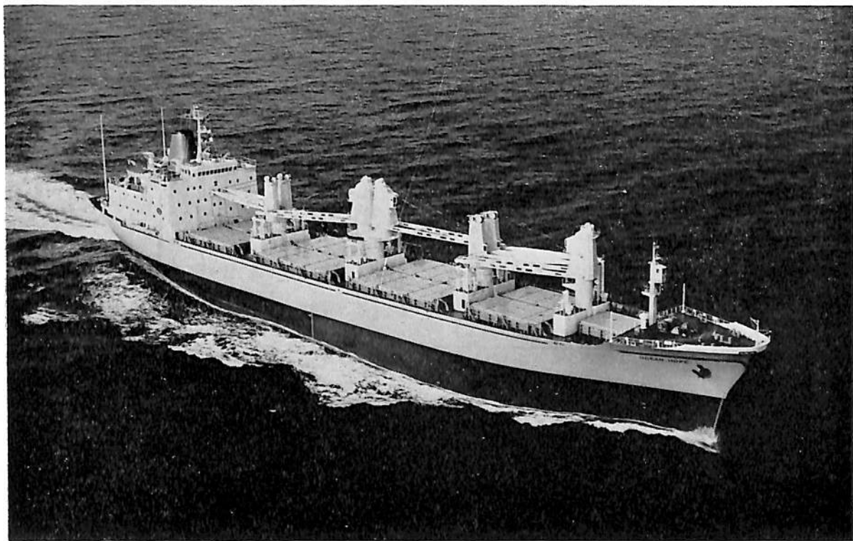
OCEAN HOPE (貨物船) 船主 Amity Shipping & Enterprises Company Inc. (リベリア) 造船所 三 菱重工業・下関造船所 総噸数 13,684.89 噸 純噸数 8,025 噸 遠洋 船級 AB 載貨重量 19,818 噸 全長 163.72 m 長(垂) 152.00 m 幅(型) 22.86 m 深(型) 14.40 m 吃水 10.738 m 満載排水量 27,004 噸 船首楼付平甲 板船 主機 スルザー 6 RND 76 型ディーゼル機関 1 基 出力 10,800 PS×118 RPM 燃料消費量 39.2 t/d 航続 距離 14,500 海里 速力 17.6 ノット 汽鐘 コクラン 1,200 kg/h 発電機 625 KVA×3 貨物倉(ベール) 26,651.5 m 3 (グリーン) 28,380.1 m 3 燃料油倉 C 1,582.4 m 3 A 238.3 m 3 清水倉 350.4 m 3 乗員 50 名 工期 47-12 -6, 48-3-5, 48-7-19 同型船 OCEAN HARMONIA, OCEAN HARVEST
