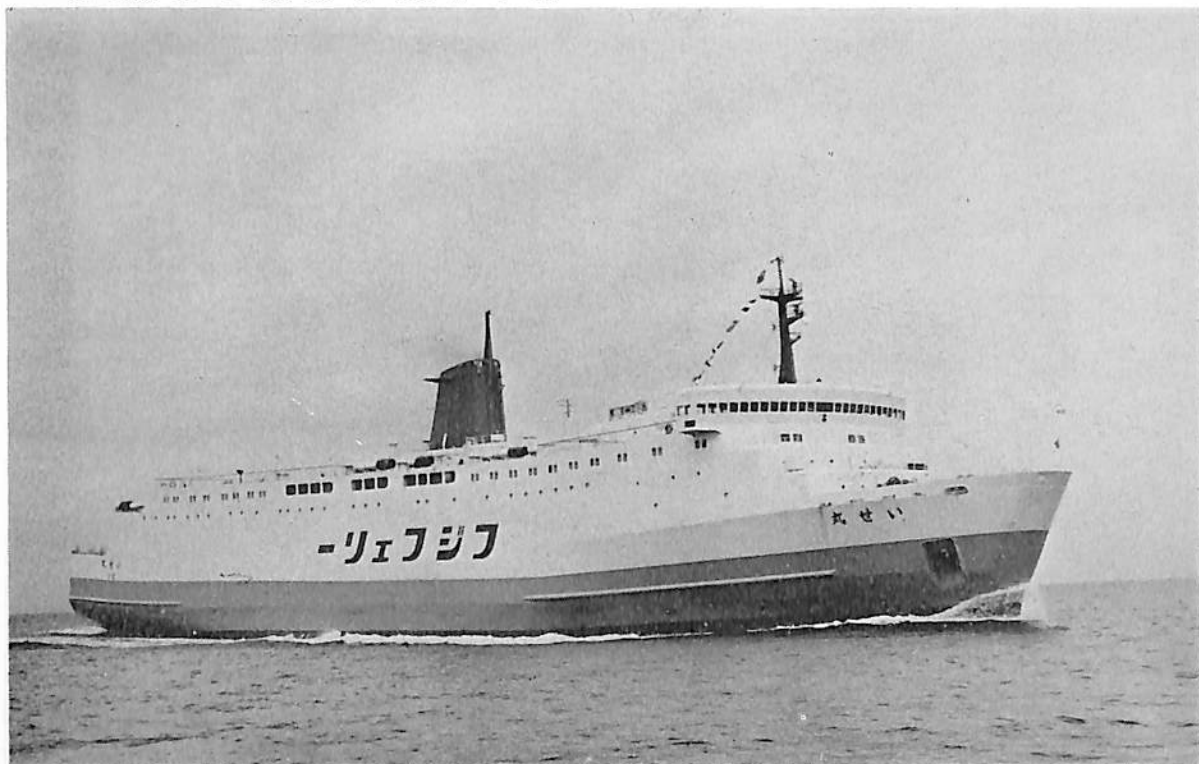
い せ 丸 (自動車航送客船) 船主 フジフェリー株式会社 造船所 林兼造船・下関造船所 総噸数 7,041.85 噸 純噸数 3,286.05 噸 沿海 載貨重量 3,037.50 噸 全長 140.85 m 長(垂) 128.00 m 幅(型) 22.40 m 深(型) 8.00 m 吃水(計画) 5.50 m 満載排水量 8,291.99 噸 全通船楼船 主機 三菱 MAN V 9 V 40/ 54 型ディーゼル機関 2 基 出力 2×8,500 PS×406.7/199 RPM 速力 約 21.50 ノット 発電機 712.5 KVA×450 V×3 旅客定員 670 名 搭載車輛 トラック 104 台 乗用車 45 台 燃料油倉 510.90 m 3 清水倉 342.20 m 3 乗員 55 名 工期 48-1-24, 48-4-5, 48-7-9 設備 フィン式スタビライザー, 船内ランプ (2)
