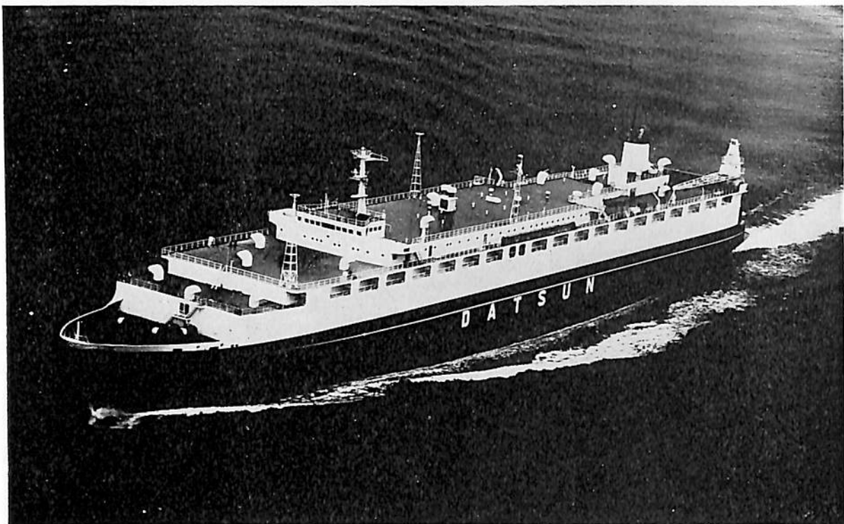
鶴 見 丸 (自動車専用船) 船主 明海海運株式会社, 大阪商船三井船舶株式会社 造船所 日立造船・舞鶴工場 総噸数 6,823.34 噸 純噸数 2,717.24 噸 遠洋 船級 NK 載貨重量 8,717 噸 全長 174.50 m 長(垂) 164.00 m 幅(型) 25.40 m 深(型) 8.10 m 吃水 7.20 m 満載排水量 17,086 噸 多層甲板船 主機 日立 B&W 9 K 62 EF 型ディーゼル機関 1 基 出力 10,540 PS×137 RPM 燃料消費量 39.21 t/d 航続距離 12,650 海里 速力 18.15 ノット 汽罐 日立フレッシングボイラー×1 発電機 500 KVA×AC 450 V×60 Hz×3 自動車搭載台数 ブルーバードセダン 約 2,950 台 料燃油倉 1,508.47 m 3 清水倉 618.65 m 3 乗員 28 名 工期 47-11-14, 48-4-14, 48-6-29
