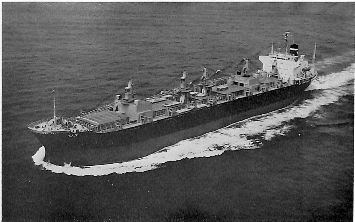
ELF (自動車兼ばら積貨物船) ・ 船主 Eagle Line Inc.(リベリア) 造船所 株式会社 名村造船所 総噸数 18,063.60 噸 純噸数 12,714 噸 遠洋 船級 AB 載貨重量 30,312 噸 全長 187.03 m 長(垂) 175.00 m 幅(型) 25.00 m 深(型) 15.40 m 吃水 10.844 m 満載排水量 39,626 噸 船首楼付平甲板型 主機 三菱スル ザー 7 RND 68 型ディーゼル機関 1 基 出力 9,820 PS×142 RPM 燃料消費量 38.8t/d 航続距離 17,600 海里 速力 14.6ノット 汽罐 コクラン型 7 kg/cm 2 , 1,500 kg/h, 169.6° C 発電機 AC 60 Hz, 640 KVA, 450 V×3 貨物倉(ベール) 36,109 m 3 (グリーン) 37,617 m 3 自動車積載量(コロナ型) 2,205 台 燃料油倉 2,264.4 m 3 清水倉 200.4 m 3 乗員 33 名 工期 47-12-11, 48-4-20, 48-7-17
