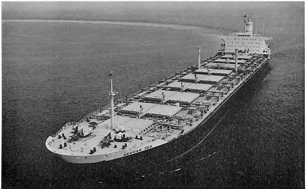
AEGEAN SEA (鉱,ばら,油運搬船) 船主 Aegean Sea Traders Corp.(リベリア) 造船所 三菱重工・広島造船所 総噸数 57,801.54 噸 純噸数 45,020.61 噸 遠洋 船級 LR 載貨重量 114,036 噸 全長 261.00m 長(垂) 247.00 m 幅(型) 40.60 m 深(型) 21.70 m 吃水 15.929 m 船首楼付平甲板船 主機 三菱スルザー9RND 90型ディーゼル機関1基 出力 22,500 PS×116 RPM 燃料消費量 約 82.7 t/d 航続距離 約 27,000 海里 速力 16.0ノット 汽鐘 三菱CE水管式 発電機 AC450 V 60 Hz 962 KVA×3 貨物倉(グリーン) 123,236 m 3 貨油倉 133,338 m 3 燃料油倉 6,183 m 3 清水倉 450 m 3 乗員 39 名 工期 47-12-19, 48-3-24, 48-7-6
