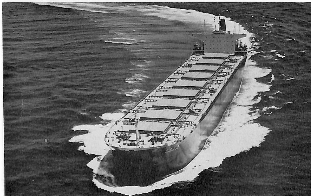
千尋山丸 (ばら積兼鉱石運搬船) 船主 大阪商船三井船舶株式会社 造船所 三井造船・玉野造船所 全長 259.82 m 長(長) 249.00 m 幅(型) 39.60 m 深(型) 22.40 m 吃水 15.629 m 総噸数 63,218.22 噸 載貨 重量 110,906 噸 貨物倉 128,182.9 m 3 速力(試) 17.56 ノット 主機 三井 B&W 7 K 90 GF 型ディーゼル機関 1 基 出力(連続最大) 23,200 PS×114 RPM 乗員 29 名 船級 NK 工期 48—2, 48—5, 48—7—31 設備 三井 B&W 7 K 90 GF 型機関は本船搭載 1 番機である。シリンダー 7, 口径 900 mm, 行程 1,800 mm, 1 シ リンダー当り 3,410 PS
