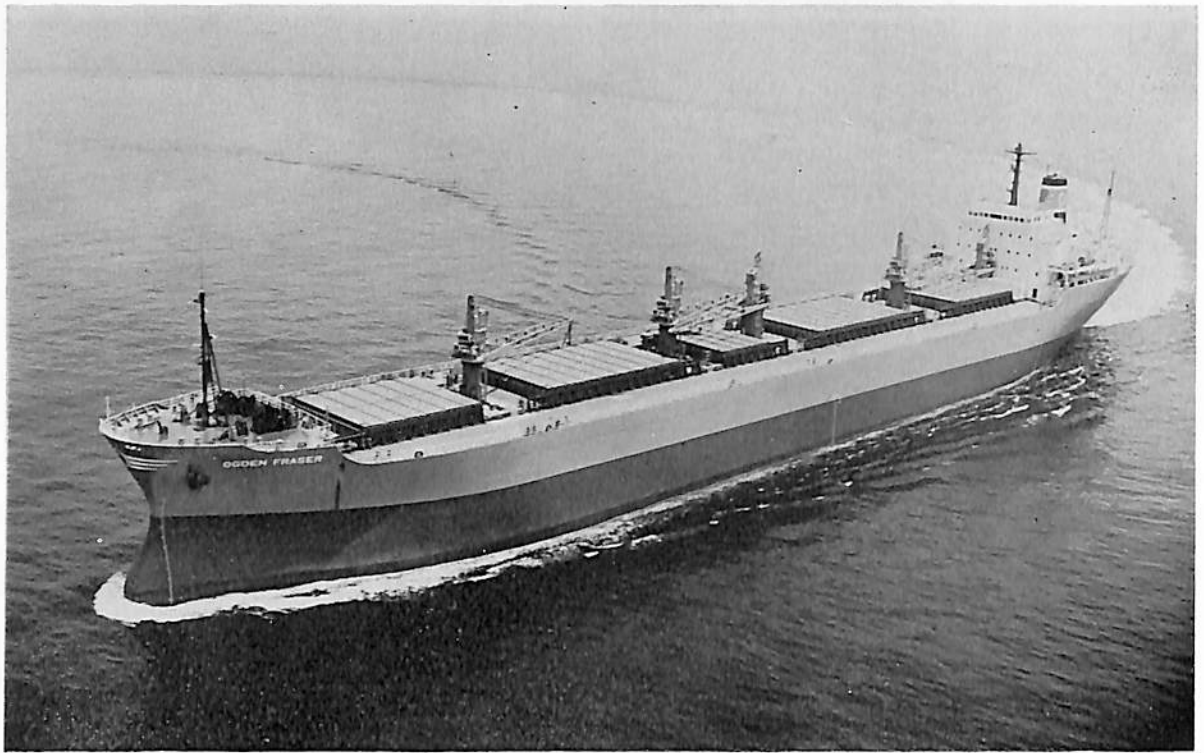
OGDEN FRASER (ばら積貨物船) 船主 Ogden Fraser Transport, Inc.(リベリア) 造船所 株式会社 大阪造船所 総噸数 19,735.11 噸 純噸数 13,890 噸 遠洋 船級 AB 載貨重量 34,365 噸 全長 185.500 m 長 (垂) 175.000 m 幅(型) 26.000 m 深(型) 15.500 m 吃水 11.151 m 満載排水量 41,748 噸 凹甲板型 主機 三 菱スルザー 7 RND 68 型ディーゼル機関 1 基 出力 10,395 PS×114.8 RPM 燃料消費量 約 41.9 t/d 航続距離 約 16,460 海里 速力 約 14.6 ノット 汽罐 コクラン缶 7 kg/cm 2 1 台 発電機 AC 450 V×480 KVA×3 貨物倉 (ベール) 41,316 m 3 (グリーン) 44,788 m 3 燃料油倉 2,164.9 m 3 清水倉 432.4 m 3 乗員 41 名 工期 48-1 -16, 48-5-18, 48-7-27
