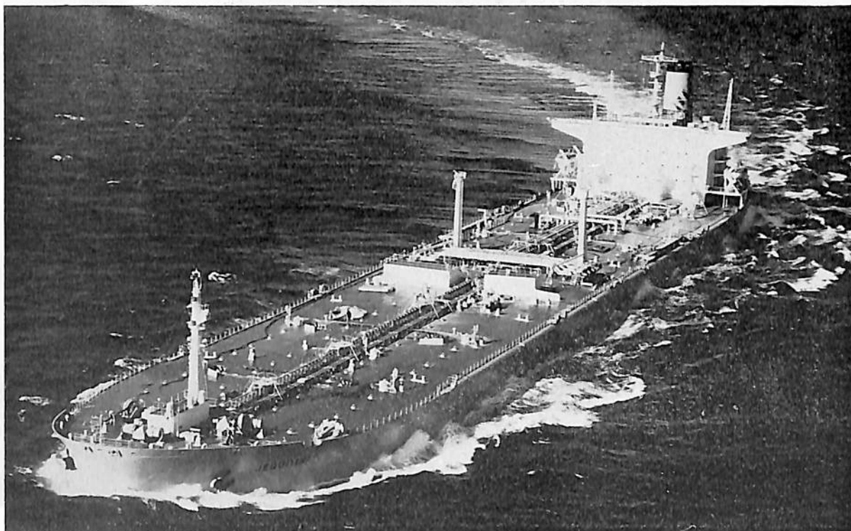
JEGQUITIBA (油槽船) 船主 Petroles Brasileiro S.A.(ブラジル) 造船所 三井造船・玉野造船所 全長 257.00 m 長(垂) 246.00 m 幅(型) 39.40 m 深(型) 22.40 m 吃水 16.918 m 総噸数 64,350.39 噸 載貨重量 116,121 噸 貨油倉 144,551.7 m 3 速力(試) 16.85 ノット 主機 三井 B&W 9 K 84 EF 型ディーゼル 機関 1 基 出力(連続最大) 23,200 PS×114 RPM 乗員 38 名 船級 LR 工期 48-1, 48-4, 48-7-24 設備 NSS システム装備, 船橋操舵室に機関部制御装置
