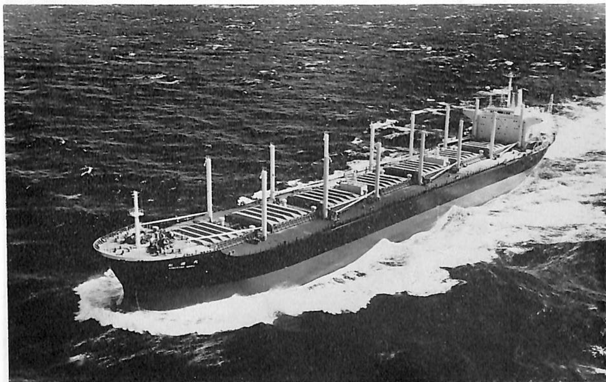
紀 国 丸 (ばら積貨物船) 船主 大阪商船三井船舶株式会社 造船所 石川島播磨重工業・名古屋造船所 総噸数 35,774.73 噸 純噸数 22,344.25 噸 遠洋 船級 NK 載貨重量 61,592 噸 全長 223.00 m 長(垂) 213.00 m 幅(型) 32.20 m 深(型) 18.30 m 吃水 12.8255 m 船首楼付平甲板型 主機 IHI スルザー-7 RND 76 型ディーゼル機関 1 基 出力 11,900 PS × 115.6 RPM 燃料消費量 45.12 t/d 航続距離 21,800 海里 速力 14.40 ノット 汽罐 立型横柱管式 発電機 420 KW × AC 60 Hz × 450 V × 3 貨物倉(グレーン) 74,064.1 m 3 燃料油倉 C 3,734 m 3 A 216 m 3 清水倉 601.5 m 3 乗員 32 名 工期 47-7-22, 47-11-20, 48-3-20, M0 船
