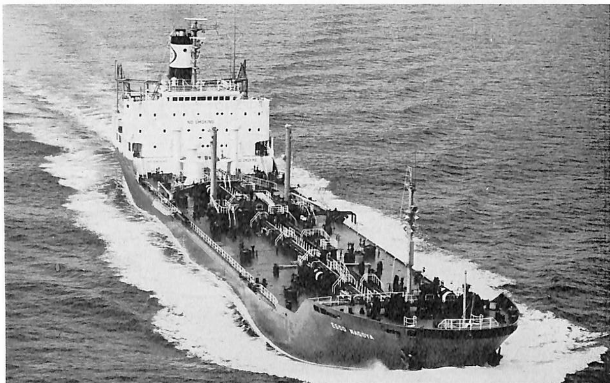
ESSO NAGOYA (油槽船) 船主 Esso Tankers, Inc. (リベリア) 造船所 日立造船・向島工場 総噸数 12,805.72 噸 純噸数 2,578 噸 遠洋 船級 AB 載貨重量 22,346 噸 全長 161.20 m 長(垂) 152.00 m 幅(型) 23.50 m 深(型) 12.75 m 吃水 32'-1 5 / 8 " 一層甲板船 主機 日立 B&W 7 K 62 EF 型ディーゼル機関 1 基 出力 8,600 PS×140 RPM 燃料消費量 35.3 t/d 航続距離 10,000 海里 速力 15.0 ノット 汽罐 日立 2 胴水管式×1 発電機 687.5 KVA×AC 450 V×60 Hz×3 貨油倉 930,517 ft 3 燃料油倉 66,843 ft 3 清水倉 6,659 ft 3 乗員 36 名 工期 47-12-11, 48-3-31, 48-7-11 設備 機関部にセントラル清水冷却システム
