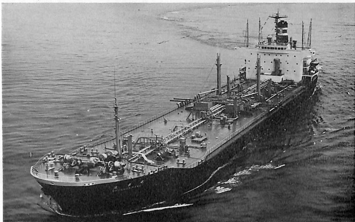
流春丸(油槽船) 船主 三菱商事株式会社 造船所 尾道造船株式会社 総噸数 21,452.23 噸 純噸数 13,160.83 噸 遠洋 船級 NK 載貨重量 37,837.00 噸 全長 187.00 m 長(垂) 178.00 m 幅(型) 28.40 m 深(型) 15.00 m 吃水 11.024 m 満載排水量 45,978.00 噸 平甲板船 主機 三菱スルザー 7 RND 76 型ディーゼル機関 1 基 出力 12,600 PS×118 RPM 燃料消費量 46.8 t/d 航続距離 12,100 海里 速力 15.30 ノット 汽罐 2 胴水管式 発電機 640 KW×AC 450 V×2 貨油倉 45,321.185 m 3 燃料油倉 1,837.44 m 3 清水倉 356.45 m 3 乗員 27 名 工期 47-12-21, 48-4-30, 48-7-21
