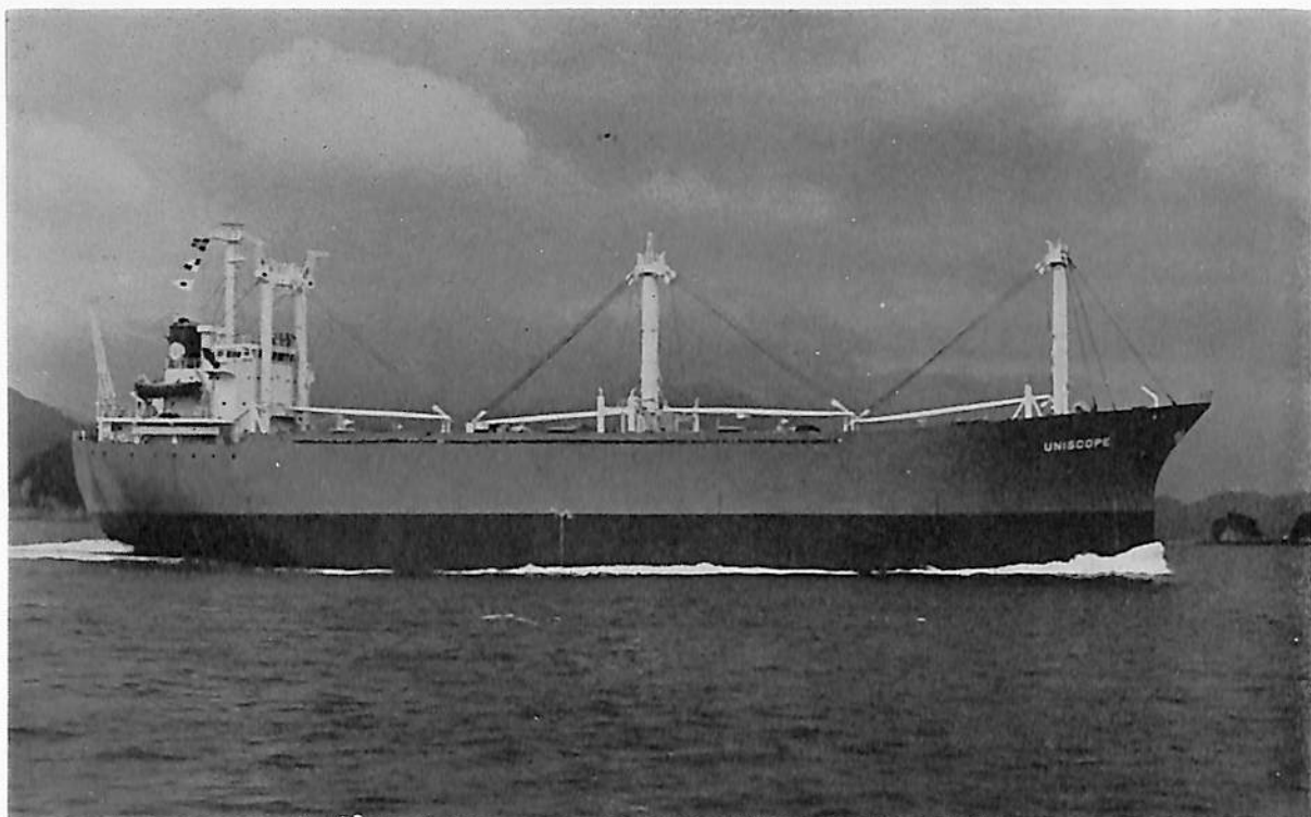
UNISCOPE (貨物船) 船主 Universe Transportation Inc. (リベリア) 造船所 今治造船株式会社・今治工場 総噸数 3,717.12噸 純噸数 2,170.06噸 遠洋 船級 LR 載貨重量 7,628.56噸 全長 108.00m 長(垂) 98.00m 幅(型) 17.20m 深(型) 13.30m 吃水 7.700m 満載排水量 10,095.4噸 全通甲板型 主機 阪神内然機 6LU54 型ディーゼル機関×1基 出力 3,825PS×218RPM 燃料消費量 14.04t/d 航続距離 10,200海里 速力 12.2 ノット 発電機 250KVA×445V×2 貨物倉(ベール) 13,520m 3 (グレーン) 14,434m 3 清水倉 413.96m 3 燃料 油倉 632.42m 3 乗員 30名 工期 47-12-18, 48-7-31, 48-9-12
