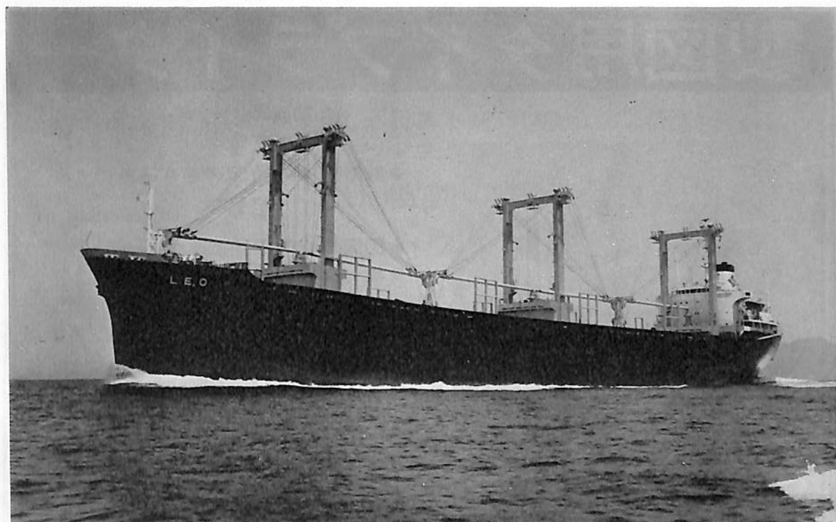
LEO (木材兼ばら積貨物船) 船主 Cassiopeia Shipping Co., Ltd. (リベリア) 造船所 常石造船株式会社 総噸数 14,866.93噸 純噸数 9,970.07噸 遠洋 船級 BV 載貨重量 27,862噸(木材) 全長 175.20m 長(垂) 165.00m 幅(型) 25.00m 深(型) 14.00m 吃水(木材) 10.783m 満載排水量(木材) 35,095噸 凹甲板型 主機三井 B&W 7 K62 E F 型 ディーゼル機関 1 基 出力 8,600 BPS × 140 RPM 燃料消費量 33.6t/d 航続距離 約 15,100 海里 速力 14.8ノット 汽罐 コ克蘭ボイラ 8 kg/cm 2 × 1 発電機 ディーゼル発電機 440KW × 2 貨物倉(ベール) 34,198.5m 3 (グレーン) 34,893.4m 3 清水倉 293.2m 3 燃料油倉 F.O. 1,592.2m 3 D.O. 248.6m 3 乗員 45名 工期 47-11-13, 48-2-7, 48-6-7
