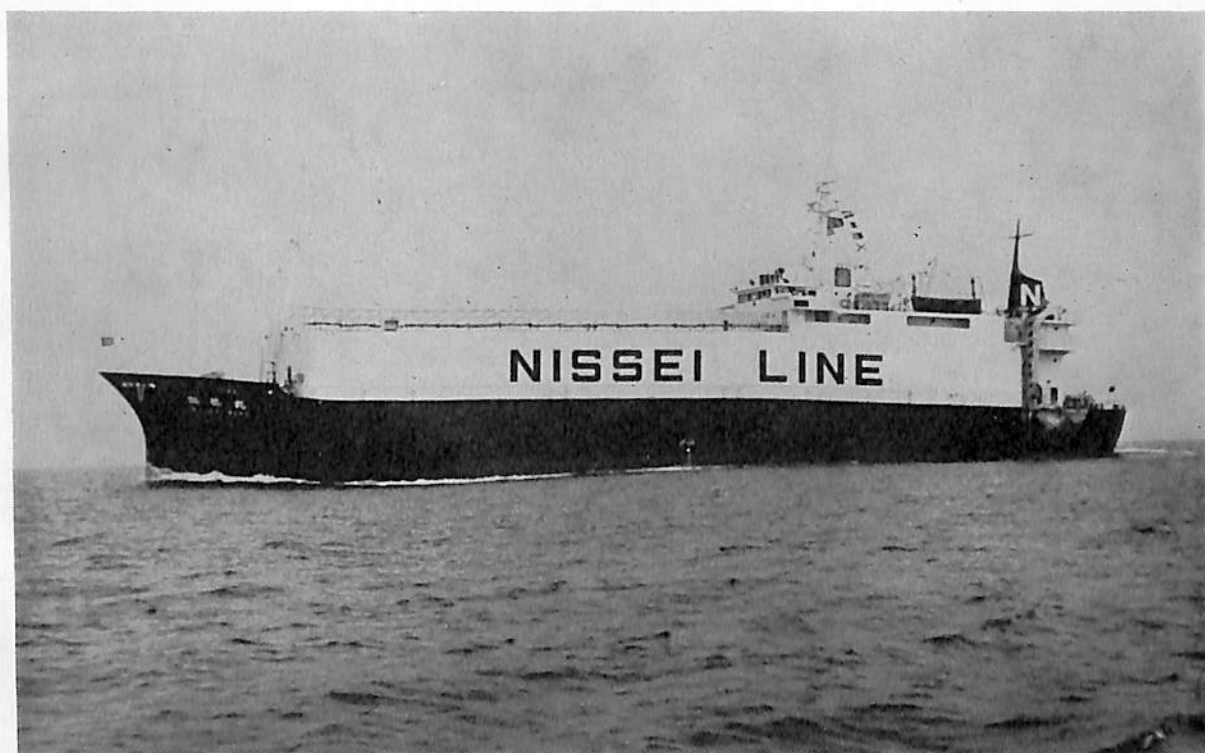
瑞 勢 丸 (自動車専用船) 船主 (三菱信託船舶) 日勢海運株式会社 造船所 本田造船株式会社 総噸数 1,515.71噸 純噸数 848.15噸 近海 載貨重量 2,997.76噸 長(垂) 80.00m 幅(型) 14.50m 深(型) 8.30m 吃水 5.014m 満載排水量 4,400噸 5層遮浪甲板型 主機 横田鉄工所 GSHC 641型 ディーゼル機関 1基 出力 2,200 PS×260 RPM 燃料消費量 160g/ps 航続距離 8,000海里 速力 14ノット 発電機 145 KVA×2 清水倉 51m 3 燃料油倉 330m 3 乗員 20名 工期 48-5, 48-8, 48-9 特徴 Aデッキを油圧駆動で吊上げ方式とし、バストラックの搭載に仮なるようにした。
