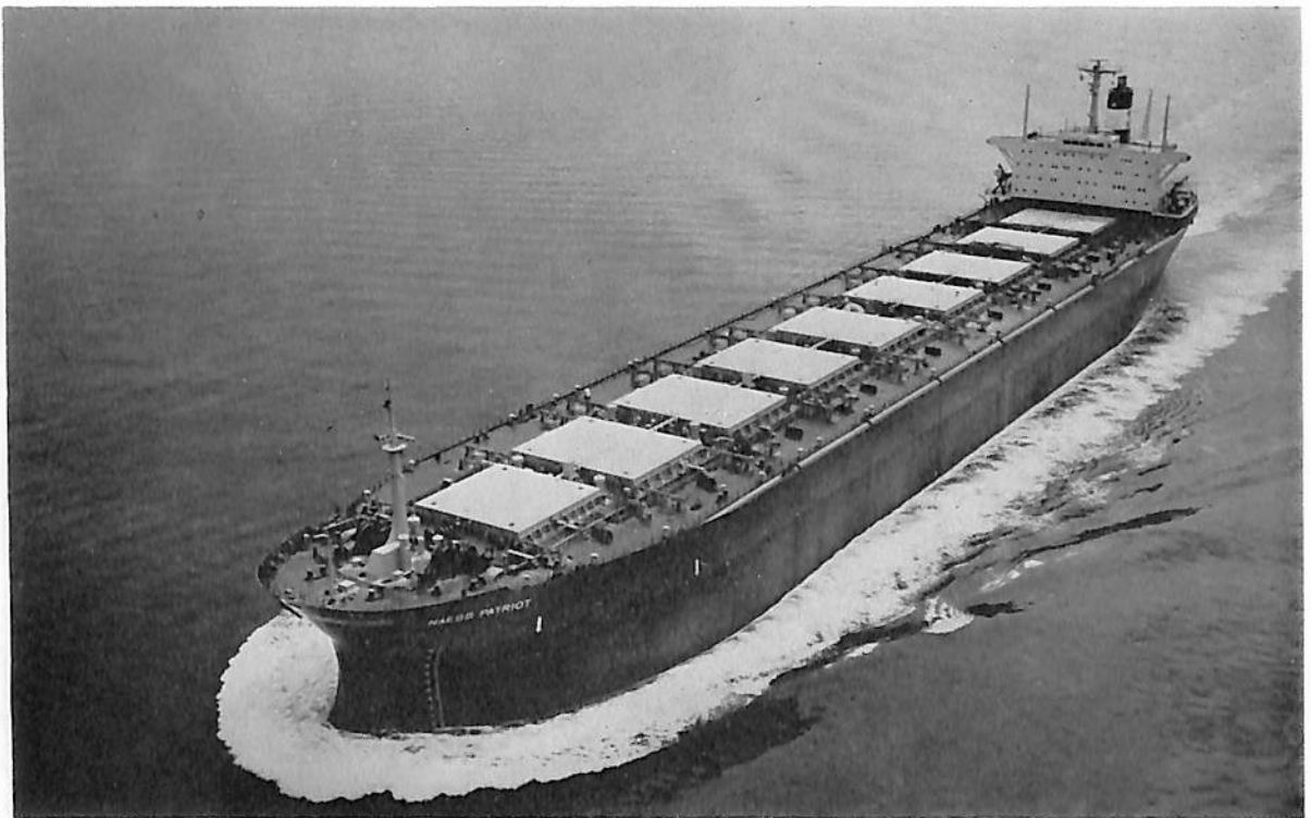
NAESS PATROT (ばら積貨物船) 船主 Zapata Naess Shipping Co.Ltd. (英) 造船所 三菱重工業・広島造船所 総噸数 69,903.56噸 純噸数 44,079.18噸 遠洋 船級 AB 載貨重量 127,283噸 全長 261.00 m 長(垂) 247.00 m 幅(型) 40.60 m 深(型) 24.00 m 吃水 17.616 m 満載排水量 150,385噸 平甲板型主機三菱スルザー-8 RND90型ディーゼル機関1基 出力 20,880 PS×118 RPM 燃料消費量 75.4 t/d 航続距離23,200海里 速力 15.5ノット 汽罐 コクランボイラー×1 発電機 8SH24 A C型×3-貨物倉(グレーン) 139,967.2 m 3 清水倉 628.8 m 3 燃料油倉 6,616.3 m 3 乗員 56名 工期 48-3-27, 48-6-20, 48-9-27
