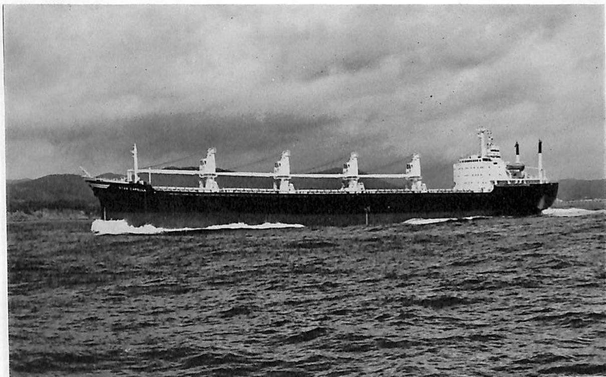
STAR CAPELLA (ばら積貨物船) 船主 Iriquois Shipping Corp., Inc. (ギリシャ) 造船所 函館ドック株 式会社・函館造船所 総噸数 14,667.27噸 噸数 9,124.98噸 遠洋 船級 LR 載貨重量 26,899噸 全長 177.94 m 長(垂) 167.80m 幅(型) 22.86m 深(型) 14.71m 吃水 10.689m 満載排水量 33,269Lt 凹型甲板船 主 機 IHI-スルザー6RND76型ディーゼル機関1基 出力 10,800PS×117.8RPM 燃料消費量 40.8t/d 航続距 離 14,550海里 速力 15.2ノット 汽罐 1,200kg/h×7kg/cm 2 G×1基 発電機 A.C.550KVA(440KW)×3 貨物 倉(ベール) 32,284m 3 (グリーン) 32,639m 3 清水倉 282m 3 燃料油倉 2,017m 3 乗員 48名 工期 48-3-13, 48-6-20, 48-9-21
