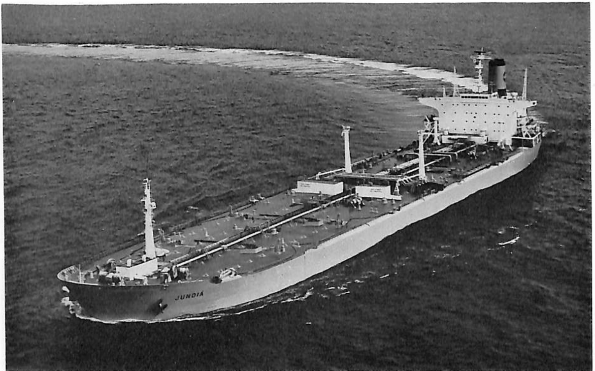
JUNDIA (油槽船) 船主 Petroles Brasileiro S.A (ブラジル) 造船所 三井造船・玉野造船所 総噸数 64,350.35噸 載貨重量 116,126噸 全長 257.00m 長(垂) 246.00m 幅(型) 39.40m 深(型) 22.40m 吃水 16.918m 主機 三井B&W 9 K84 E F型ディーゼル機関1基 速力 16.8ノット 出力 23,200PS×114RP M 船級 LR 工期 48-4, 48-6, 48-10-3 設備 NNS装置, 船橋操舵室に機関部制御装置
