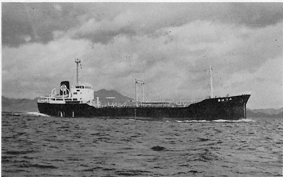
み つ は ま (油槽船) 船主 三津浜汽船株式会社 造船所 檜垣造船株式会社 総噸数 997.72噸 純噸数 626.07噸 沿海 載貨重量 2,268.62噸 全長 73.350m 長(垂) 68.00m 幅(型) 11.80 m 深(型) 5.60m 吃水 5.020m 満載排水量 2,995.00噸 凹甲板船尾機関型 主機 阪神内然機 整形単動4衝程 ディーゼル機関1基 出力 1,785PS×298RPM 燃料消費量 6.732t/d 航続距離 2,640海里 速力 12.237ノット 発電機 100KVA×2 貨油倉 2,747.154m 3 清水倉 57.615m 3 燃料油倉 76.17m 3 乗員 13名 工期 48-4-23, 48-7-5, 48-9-8
