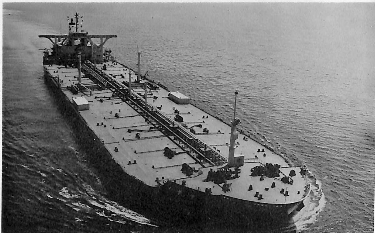
豊 燕 丸 (油槽船) 船主 新和海運株式会社, 萬野汽船株式会社, 丸善海運株式会社 造船所 三菱重工業・長崎造船所 総噸数 116,150.34噸 純噸数 90,317.98噸 遠洋 船級 NK 載貨重量 237,183噸 全長 321.82m 長(垂) 304.00m 幅(型) 52.40m 深(型) 25.70m 吃水 19.85m 船首樓付平甲板船 主機 三菱2段減速装置付タービン×1 出力 34,000PS×90RPM 燃料消費量 166.5t/d 航続距離 17,000海里 速力 15.80ノット 汽罐 三菱C.E.型×2 貨油倉 289,267.3m 3 清水倉 760.1m 3 燃料油倉 8,270.8m 3 乗員 36名 工期 48-2-2, 48-5-24, 48-9-18
