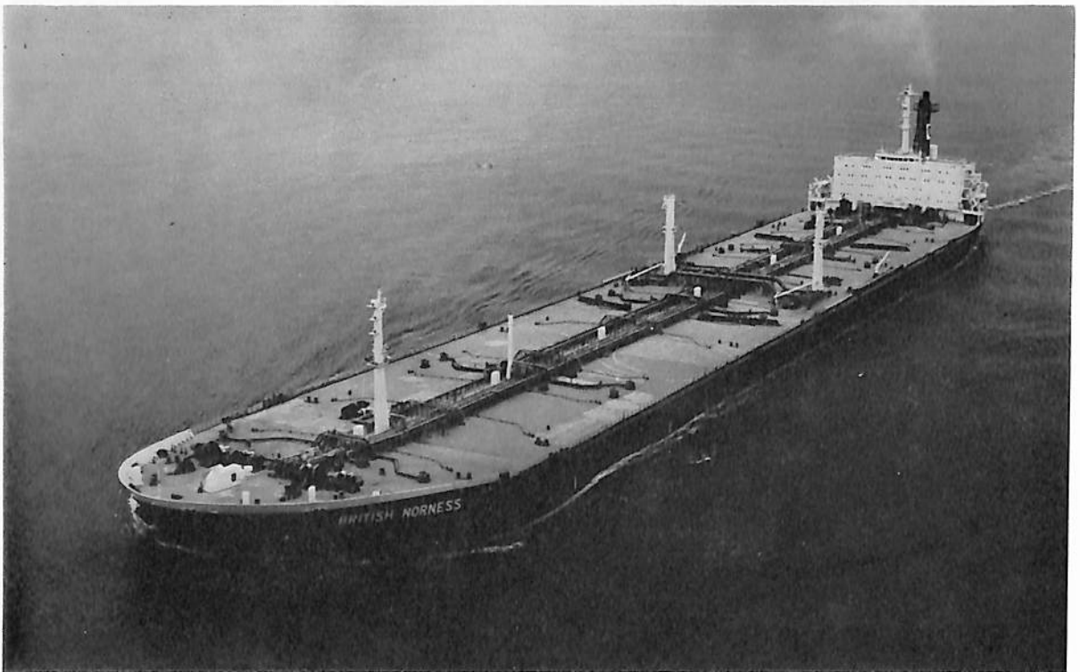
BRITISH NORNESS (油槽船) 船主 Horcape Shipping Company (バーミユタ) 造船所 三菱重工業・長 崎造船所 総噸数 132,941.62噸 純噸数 108,734.66噸 遠洋 船級 LR 載貨重量 269,350噸 全長 328.612m 長(垂) 323.00m 幅(型) 53.60m 深(型) 26.40m 吃水 20.630m 平甲板船 主機 三菱2段減速装置付ター ビン×1 出力 30,000PS×88RPM 燃料消費量 152t/d 航続距離 24,650海里 速力 14.8ノット 汽罐 C.E. V2M-8W型×2 発電機 2×1,400KW, AC450×2 貨油倉 12,875.5m 3 清水倉 422.5m 3 燃料油倉 347,617.8 m 3 乗員 53名 工期 48-3-1, 48-6-15, 48-9-23
