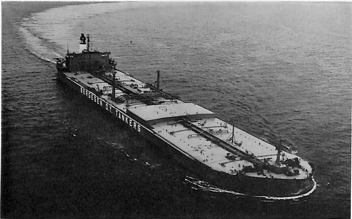
BERGE DUKE (油槽船) 船主 Sig Bergesen d.y. & Co. (ノルウェー) 造船所 三井造船・千葉造船所 総噸数 139,775.62噸 純噸数 104,072.54噸 遠洋 船級 LR 載貨重量 279,518Lt 全長 342.900m 長(垂) 329.184m 幅(型) 51.816m 深(型) 27.737m 吃水 21.773m 満水排水量 320,400Lt 中央船楼付平甲板型 主機 三井B&W 9 K98FF型ディーゼル機関1基 出力 32,100PS×103RPM 燃料消費量 118t/d 航続距離 25,010海里 速力 15.15ノット 発電機 1,000KW×1 945KW×2 貨油倉 342,043m 3 清水倉 715m 3 燃 料油倉 9,499m 3 乗員 44名 工期 48-1-23, 48-6-15, 48-9-28 設備 "UMS" 取得, IMCO タンク容積制限適用
