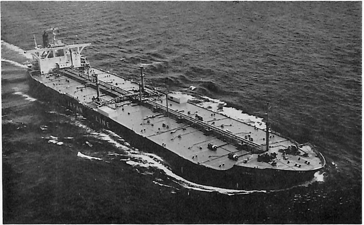
ジャパン アスター (油槽船) 船主 ジャパンライン株式会社 造船所 三菱重工業・長崎造船所 総噸数 117,596.18噸 純噸数 88,279.83噸 遠洋 船級 NK 載貨重量 237,307噸 全長 321.82m 長(垂)304.00 m 幅(型) 52.40m 深(型) 25.70m 吃水 19.85m 船首楼付平甲板船 主機 三菱船用パッケージド減速装置付 タービン×1基 出力 34,000PS×90RPM 燃料消費量 166.5t/d 航続距離 16,500海里 速力 15.8ノット 汽 罐 三菱CE-V2M-8W×2 貨油倉 289,267.3m 3 清水倉 760.1m 3 燃料油倉 8,265.5m 3 乗員 36名 工期 48 -1-12, 48-5-18, 48-9-4 同型船 ジャパン アドリス
