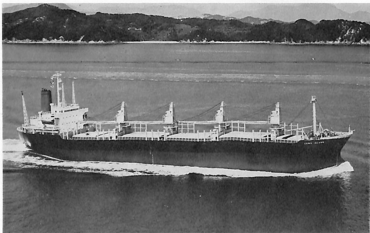
CEBU ISLAND (貨物船) 船主 Luzon Shipping S. A. (パナマ) 造船所 今治造船株式会社・丸亀工場 総噸数 16,370.08噸 純噸数 10,850.78噸 遠洋 船級 NK 載貨重量 29,648噸 全長 175.17m 長(垂) 165.00 m 幅(型) 26.00m 深(型) 14.50m 吃水 10.300m 満水排水量 37,147噸 ウェル甲板型 主機 三菱スルザー 7RND68型ディーゼル機関1基 出力 10,395PS×145RPM 燃料消費量 41.48t/d 航続距離 16,600海里 速 力 14.5ノット 発電機 500KVA×450V×2 貨物倉(ベール) 35,205m 3 (グレーン) 36,393m 3 清水倉 404.90m 3 燃料油倉 2,264.51m 3 乗員 37名 工期 48-1-30, 48-7-8, 48-8-31
