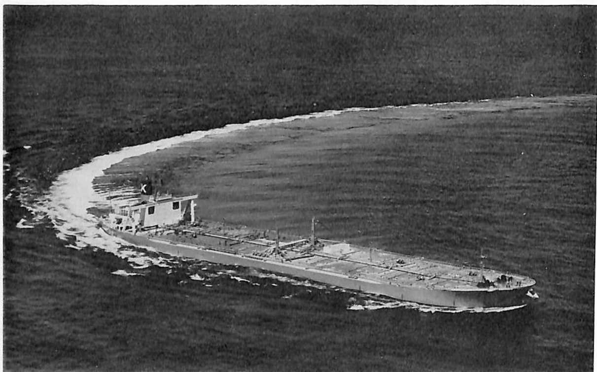
HARMONY VENTURE (油槽船) 船主 Prestige Carriers, INC., (リベリア) 造船所 川崎重工業・坂出工場 総噸数 104,918.43噸 純噸数 88,071.37噸 遠洋 船級 BV 載貨重量 231,992噸 全長 319.30m 長(垂) 305.00m 幅(型) 53.00m 深(型) 25.30m 吃水 19.5365m 満載排水量 266,205噸 主機 川崎UA-360型タービン×1 出力 35,000PS×89RPM 燃料消費量 170.86t/d 航続距離 17,800海里 速力 16.5ノット 汽罐 川崎UMG 72/56型×2 燃料油倉 8,739.39m 3 清水倉 130.94m 3 乗員 38名 工期 47-11-9, 48-5-26, 48-9-6
