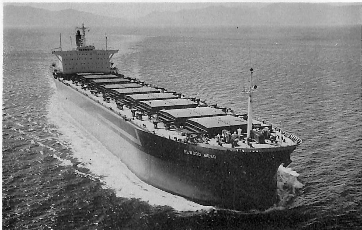
ELWOOD MEAD (ばら積貨物船) 船主 United International Bulk Carriers (リベリア) 造船所 三菱重工・広島造船所 総噸数 59,192.71噸 純噸数 45,340噸 遠洋 船級 AB 載貨重量 127,497噸 全長 261.00m 長(垂) 247.00m 幅(型) 40.60m 深(型) 24.00m 吃水 57'-9 1/2" 満載排水量 148,000噸 平甲板型 主機 三菱スルザー 8 RND90型ディーゼル機関1基 出力 20,000PS×116RPM 燃料消費量 72.0t/d 航続距離 26,000海里 速力 14.8ノット 発電機 AC45V, 850KVA×3 燃料油倉 6,099.8m 3 清水倉 698.0m 3 乗員 50名 工期 48-5-15, 48-8-6, 48-10-31
