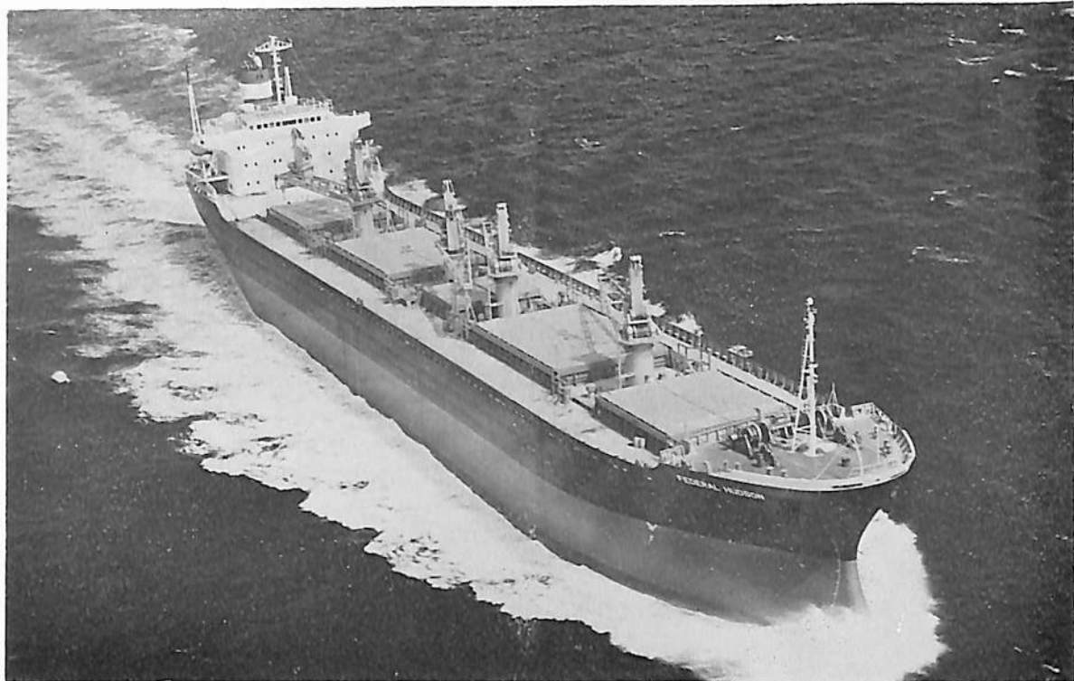
FEDERAL HUDSON (ばら積貨物船) 船主 Far Eastern Shipping Ltd.(リベリア) 造船所 株式会社大阪造船所 総噸数 19,831.03噸 純噸数 13,973噸 遠洋 船級 AB 載貨重量 34,186噸 全長 185.500m 長(垂)175.000m 幅(型) 26.000m 深(型) 15.500m 吃水 11.526m 満載排水量 41,764噸 凹甲板船 主機 三菱ズルザー 6 RND76型ディーゼル機関1基 出力 10,800PS×117.8RPM 燃料消費量 43.2t/d 航続距離 16,400海里 速力 15.00ノット 汽罐 コクラン型コンジットボイラー7 kg/cm 2 1台 発電機 AC 450V, 500KVA 3台 貨物倉(ベール) 41,281m 3 (グレーン) 44,729m 3 清水倉 430.7m 3 燃料油倉 2,572.8m 3 乗員 38名 工期 48-5-21, 48-8-1, 48-10-11
