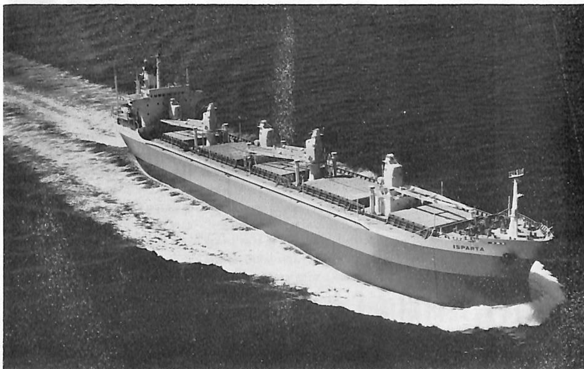
ISPARTA (ばら積貨物船) 船主 D.B. Turkish Cargo Lines (Turkey) 造船所 株式会社名村造船所 総噸数 16,964.24噸 純噸数 11,079噸 遠洋 船級 AB 載貨重量 27,003噸 全長 177.03m 長(垂) 167.00m 幅(型) 22.90m 深(型) 14.50m 吃水 10.405m 満載排水量 33,497噸 凹甲板船 主機 三菱重工SULZER 7 RND 68型ディーゼル機関1基 出力 9,820PS×142RPM 燃料消費量 C重油 37.2t/d A 1.9t/d 航続距離 15,900海里 速力 15ノット 汽罐 コクランボイラ 7 kg/cm 2 発電機 437.5KVA(350KW), 450V×3 貨物倉(ベール)32,552m 3 (グレーン) 34,204m 3 清水倉 161.0m 3 燃料油倉 1,888.7m 3 乗員 41名 工期 48-4-9, 48-7-20, 48-10-16
