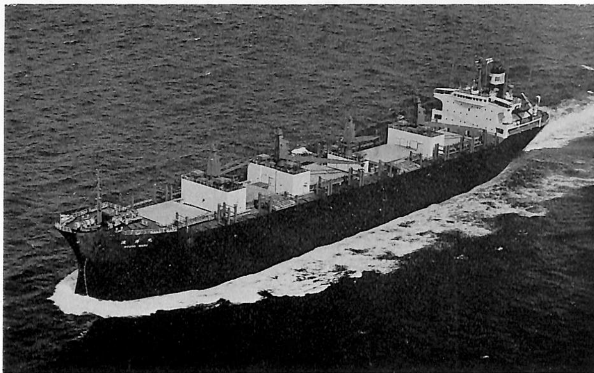
流 洋 丸 (自動車兼ばら積運搬船) 船主 流通海運株式会社 造船所 林兼造船株式会社・長崎造船所 総噸数 24,658.98噸 純噸数 16,842.65噸 遠洋 船級 NK 載貨重量 38,927.65噸 全長 196.00m 長(垂) 183.00m 幅(型) 27.60m 深(型) 17.00m 吃水 12.217m 満載排水量 50,663.54噸 凹甲板型 主機 三井B&W 7 K74E F型ディーゼル機関1基 出力 11,900PS×120RPM 燃料消費量 44.5t/d 航続距離20,000海里 速力 15.75ノット 汽罐 横煙管式 1,200kg/h 1台 発電機 720KVA×2台 貨物倉(グレーン) 47,079.12 m 3 清水倉 410.80m 3 燃料油倉 2,662.55m 3 乗員 30名 工期 48-3-16, 48-7-2, 48-9-28 自動車積載量(中型車) 2,500台
