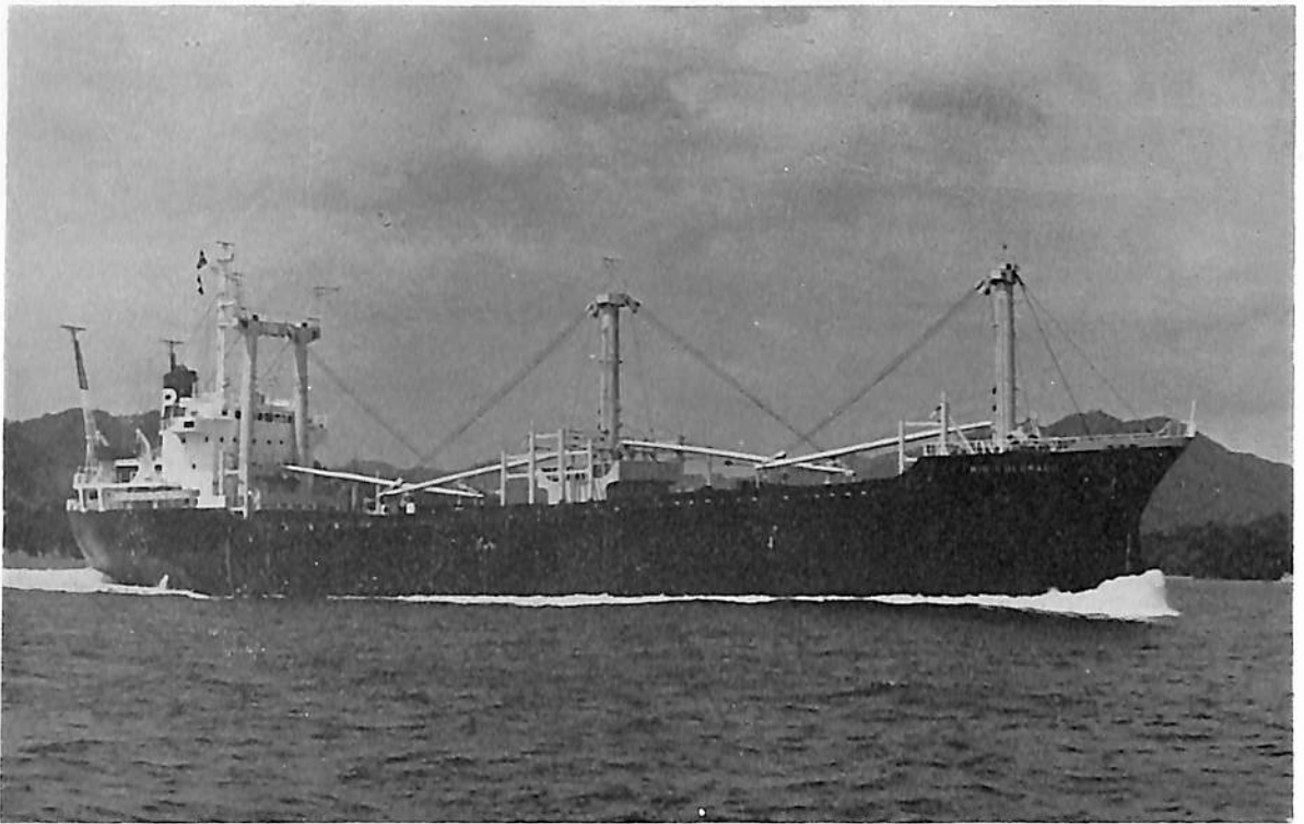
RIO COLORADO (貨物船) 船主 La Palma Navegacion S.A. (パナマ) 造船所 今治造船株式会社今治工場 総噸数 4,837.17噸 純噸数 3,368.99噸 遠洋 船級 NK 載貨重量 8,621.67噸 全長 110.15m 長(垂) 102.00 m 幅(型) 18.30m 深(型) 9.20m 吃水 7.230m 満水排水量 10,450.60噸 ウエル甲板型 主機 阪神内燃機俵 6 L U 54型ディーゼル機関1基 出力 3,825PS×218RPM 燃料消費量 16.524t/d 航続距離 12,000海里 速力 12.8ノット 汽罐 立型水管式 800kg/h 発電機 250KVA×2 貨物倉(ベール) 9,456.06m 3 (グレーン) 10,318 m 3 清水倉 560.22m 3 燃料油倉 706.11m 3 乗員 30名 工期 48-3-29, 48-8-21, 48-10-4
