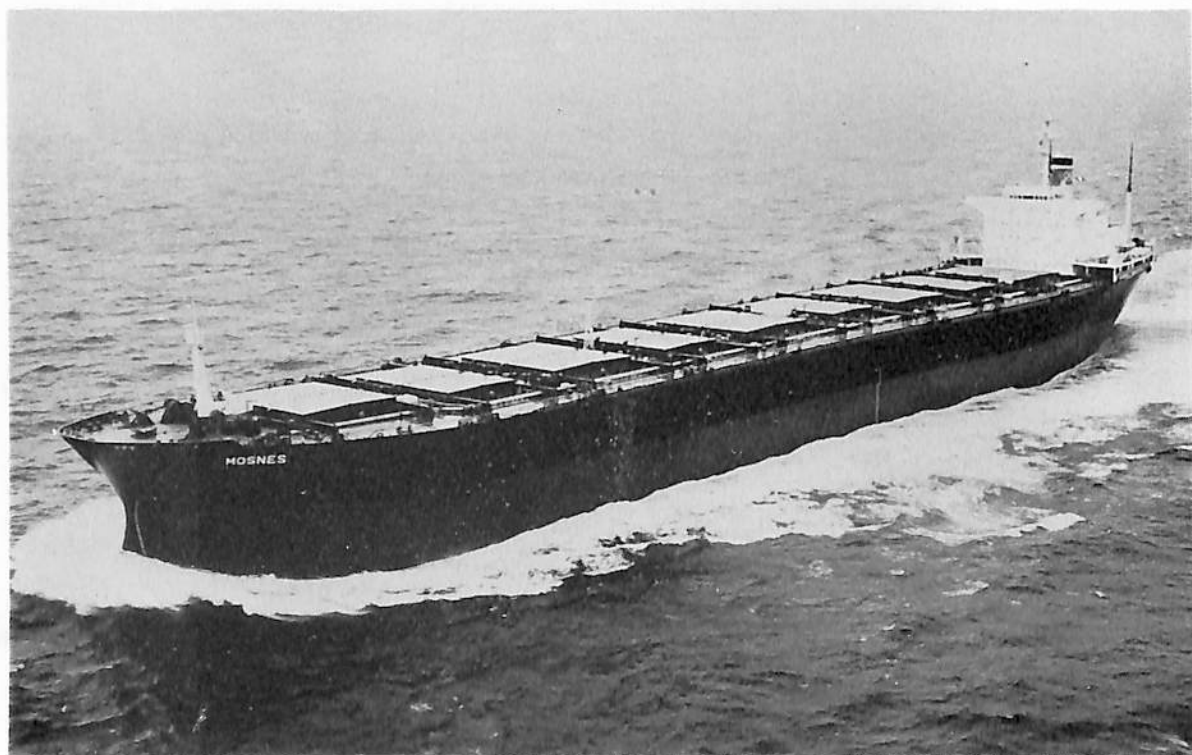
MOSNES (ばら積貨物船) 船主 A/S Mosbulkerø (ノルウェー) 造船所 住友重機械工業・浦賀造船所 総噸数 64,731.40噸 船級 NV 載貨重量 117,738噸 長(垂) 244.00m 幅(型) 40.20m 深(型) 23.90m 吃水 16.85m 主機 住友スルザー 8 RND90型ディーゼル機関1基 出力 23,200PS×122RPM 速力 14.9ノット 工期 48-4-19, 48-7-26, 48-11-7
