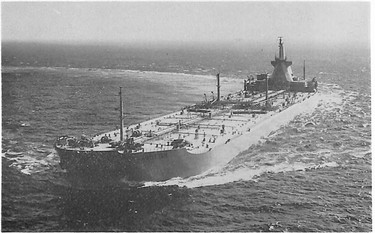
CASTLETON (油槽船) 船主 Blandford Shipping Co., Ltd. (UK) 造船所 川崎重工・坂出工場 総噸数 113,156.24噸 遠洋 船級 NV 載貨重量 231,355噸 全長 325.85m 長(垂) 313.00m 幅(型) 48.20m 深(型) 26.40m 吃水 20.498m 船首楼付平甲板型 主機 川崎重工 UA-TYPE STEAM TURBINE 出力 26,000PS×88RPM 燃料消費量 129.2t/d 航続距離 18,700海里 速力 14.6ノット 汽罐 KAWASAKI UF G 100/86型×1 発電機 2×1,200KW, 1,500KVA 貨物倉(ベール) 281,800m 3 燃料油倉 7,450m 3 清水倉 240 m 3 乗員 37名 工期 48-4-18, 48-7-12, 48-11-1 設備 タワー型ブリッジハウス採用
