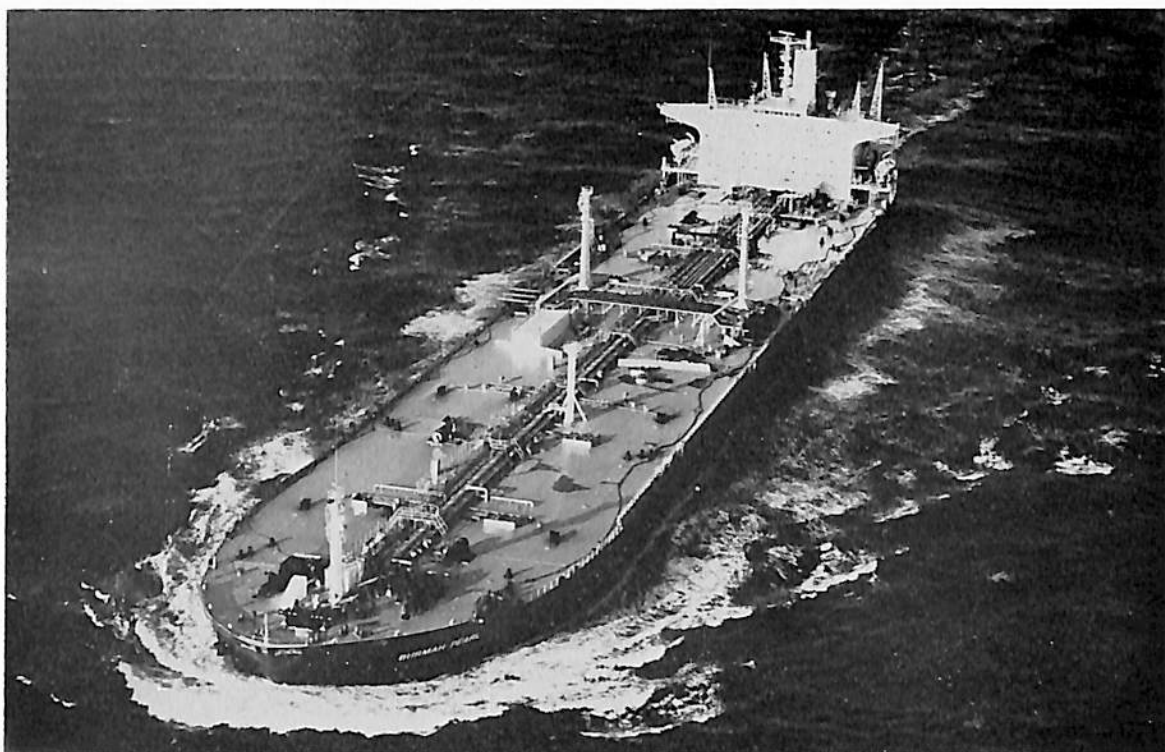
BURMAH PEARL (油槽船) 船主 Burmah Oil Tankers Ltd (バーミューダ) 造船所 三井造船・玉野造船所 総噸数 75,048.76噸 船級 LR 載貨重量 138,250噸 全長 270.50m 長(垂) 260.00m 幅(型) 44.00m 深(型) 22.40m 吃水 17.044m 主機 三井B&W 10K84E F型ディーゼル機関1基 出力 25,000PS×114RPM 速力(試) 16.75ノット 貨物倉 166,719.3m 3 工期 48-5, 48-8, 48-11-7 設備 LRのイナートガスシステム資格, 生活汚水処理装置, 外部電源防食装置
