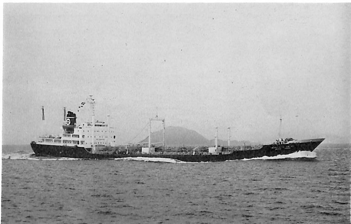
ゆうないてつと とれーだー (油送船) 船主 丸神船舶株式会社 造船所 波止浜造船株式会社 総噸数 8,348.97噸 純噸数 4,406.02噸 遠洋 船級 NK 載貨重量 13,678.90噸 全長 141.200m 長(垂) 128.000 m 幅(型) 21.000m 深(型) 11,300m 吃水 9,019m 満載排水量 18,251.700噸 凹甲板 主機 IHI スルザー 7 RND68型ディーゼル機関1基 出力 10,395PS×144.8RPM 燃料消費量 38.67t/d 航続距離 21,000海里 速力 16.00ノット 汽罐 大阪ボイラー 船用丸缶1基 15kg/cm 2 発電機 450KVA×2 貨油倉 14,644.031m 3 清 水倉 1,097.19m 3 燃料油倉 C 2,610.46m 3 A 431.21m 3 乗員 33名 工期 48-3-14, 48-6-28, 48-9- 12
