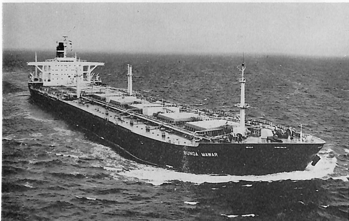
BUNGA MAWAR (鉦・油兼用船) 船主 Malayscan International Shipping Corporation 造船所 三菱重工業・横浜造船所 総噸数 81,231.28噸 純噸数 64,169噸 遠洋 船級 AB 載貨重量 169,623噸 全長 294.85m 長(垂) 280.00m 幅(型) 47.40m 深(型) 24.10m 吃水 17.922m 満載排水量 199,618噸 平甲板船 主機 三菱スルザー10RND90型ディーゼル機関1基 出力 26,100 PS×118RPM 燃料消費量 94.4t/d 航続距離 27,000海里 速力 15.3ノット 汽罐 三菱CE2胴水管ボイラー×2 発電機 AC450V, 800KW×1 貨物倉(グリーン) 89,804m 3 燃料油倉 8,033m 3 清水倉 581m 3 乗員 73名 工期 48-2-22, 48-7-23, 48-10-23 同型船 GARDEN GREEN
