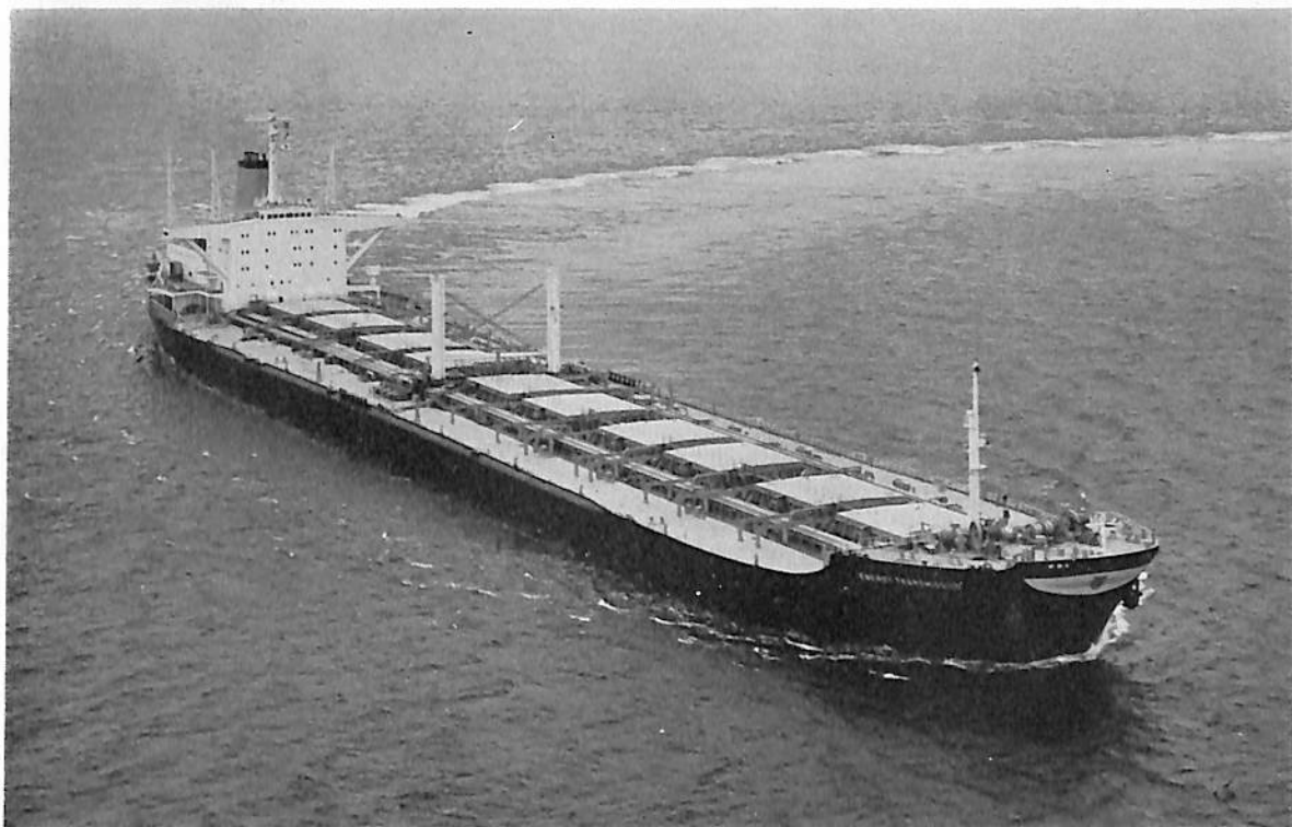
ENERGY TRANSMISSION (鉸・油兼用船) 船主 United Bulk Carrier & Tankers, Inc. (リベリア) 造船所 川崎重工業株式会社・神戸工場 総噸数 79,492.76噸 純噸数 65,560.96噸 遠洋 船級 LR 載貨重量 158,646噸 全長 289.00m 長(垂) 275.00m 幅(型) 44.00m 深(型) 24.20m 吃水 17.927m 満載排水量 186,771噸 船首楼付平甲板船 主機 川崎MANK 7 S Z105/180型ディーゼル機関1基 出力 25,200PS×102RPM 燃料消費量 95.86t/d 航続距離 33,000海里 速力 15.77ノット 汽罐 川崎BDSM72×1 発電機 AC 450V1, 287.5KVA×2 貨物倉(ベール) 87,667.5m 3 (グレーン) 197,999.2m 3 燃料油倉 8,433.4m 3 清水倉 184.9m 3 乗員 48名 工期 48-4-4, 48-7-6, 48-10-5
