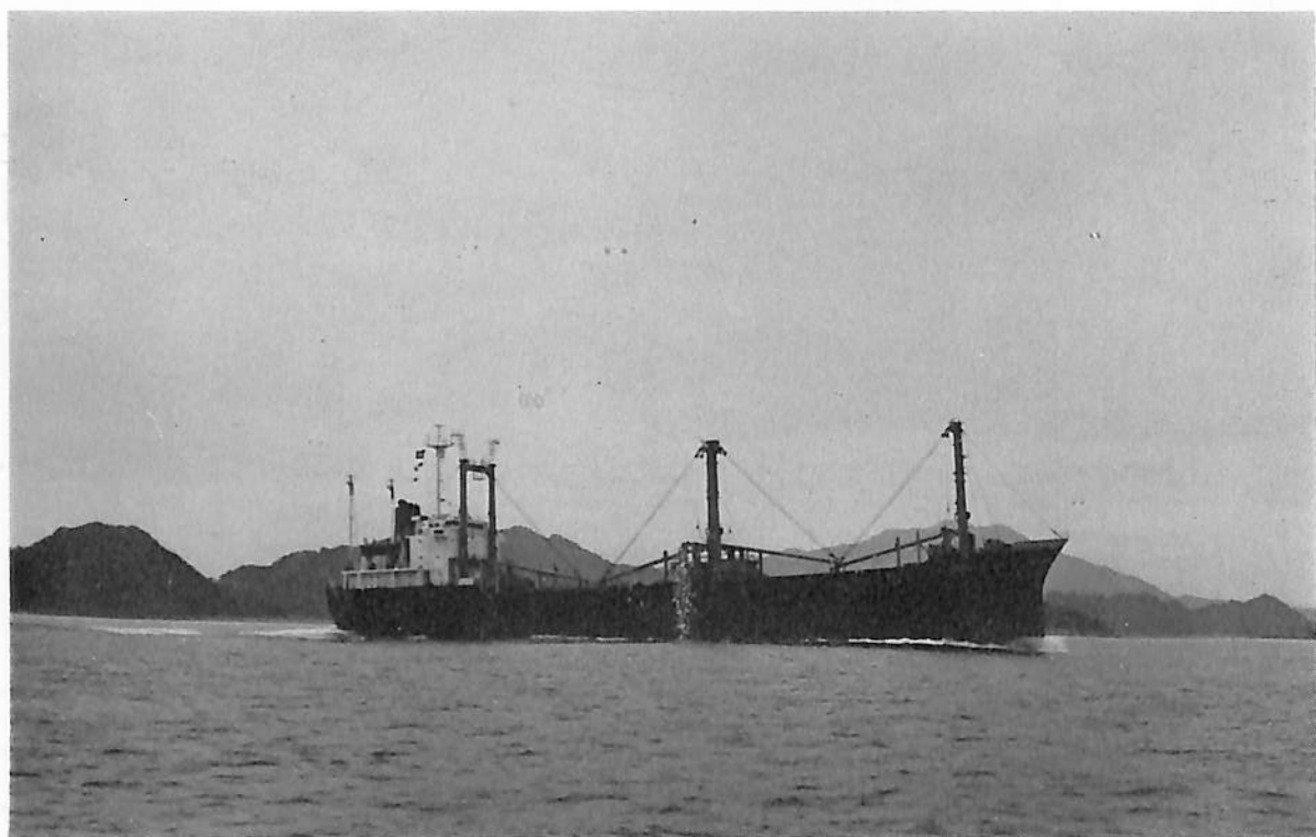
LANSING QUEEN (貨物船) 船主 Lansing Corporation (パナマ) 造船所 波止浜造船株式会社 総噸数 4,443.56噸 純噸数 2,894.13噸 遠洋 船級 NK 載貨重量 7,356.28噸 全長 110.00m 長(垂) 101.90 m 幅(型) 17.50m 深(型) 8.60m 吃水 7.042m 満載排水量 9,750.00噸 凹甲板 主機 神戸発動機6 UET45 /80D型ディーゼル機関1基 出力 3,570PS×218RPM 航続距離 12,800海里 速力 13.6ノット 汽罐 コクラン コニポジット×1 発電機 200KVA×445V×900RPM×2 貨物倉(ベール) 8,935.76m 3 (グレーン) 9,425.05 m 3 清水倉 554.73m 3 燃料油倉 A 101.10m 3 C 693.10m 3 乗員 28名 工期 48-6-1, 48-7-17, 48- 9-28
