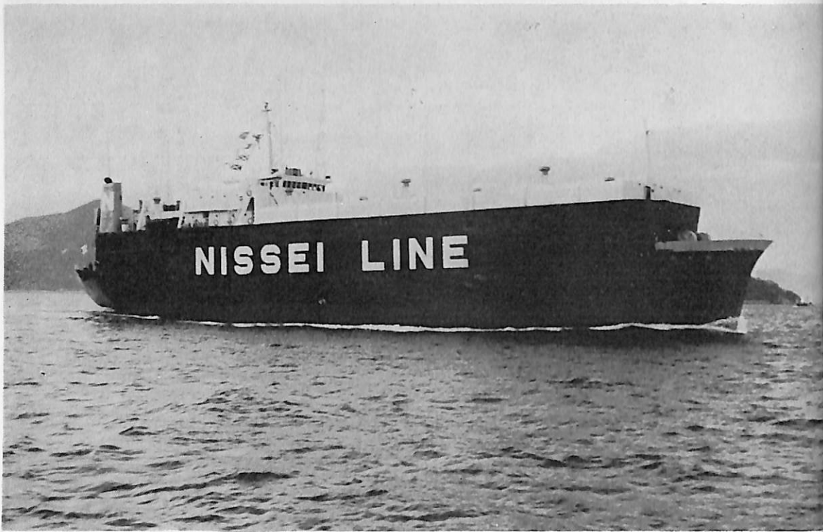
龍 勢 丸 (自動車運搬船) 船主 日勢海運株式会社 造船所 芸備造船工業株式会社 総噸数 2,371.30噸 純噸数 1,351.67噸 遠洋 載貨重量 3,877.06噸 全長 98.00m 長(垂)89.95m 幅(型)16.00 m 深(型) 7.30m 吃水 6.70m 三層甲板船尾機関型 主機 伊藤鉄工M 556H U S型ディーゼル機関1基 出力 5,000PS×320RPM 燃料消費量 155g/ps/h 航続距離 14,154海里 速力 15.64ノット 汽罐 500kg/N×7kg/ cm 2 発電機 AC445V×250KVA×2 清水倉 200.58m 3 燃料油倉 848.83m 3 乗員 23名 工期 48-6-25, 48 -8-31, 48-11-22
