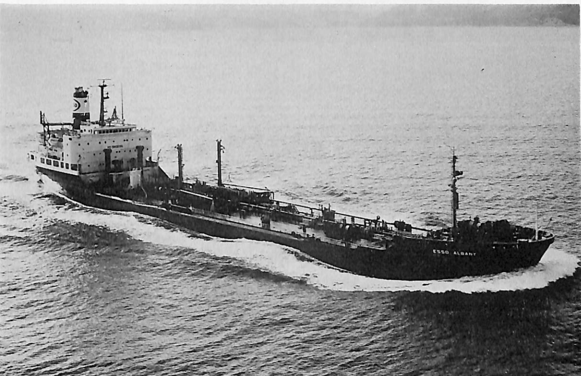
ESSO ALBANY (油槽船) 船主 Esso Tanker Inc. (リベリア) 造船所 日立造船・向島工場 総噸数 12,805.92噸 純噸数 28,463Lt 遠洋 船級 AB 載貨重量 22,367噸 全長 161.20m 長(垂) 152.00m 幅(型) 23.50m 深(型) 12.75m 吃水 33'-1 \frac{1}{2} " 満載排水量 28,463Lt 船尾楼付一層甲板船 主機 日立B & W 7 K62 E F型ディーゼル機関1基 出力 8,600PS×140RPM 燃料消費量 35.3t/d 航続距離 10,000海里 速力 15.00ノット 汽罐 日立2胴水管式 発電機 550KW, AC450,60Hz×3 貨油倉 930,517ft 3 清水倉 6.657ft 3 燃料油倉 66,843ft 3 乗員 36名 工期 48-5-31, 48-8-11, 48-11-9
