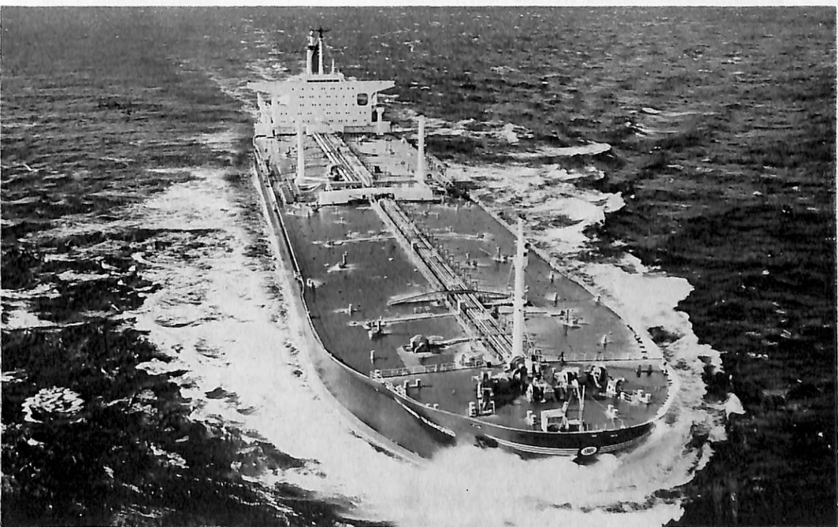
SPLENDID DIAMOND (油槽船) 船主 Financiera Panamericana Dos Rios, S.A (パナマ) 造船所 佐世 保重工業・佐世保造船所 総噸数 103,960.95噸 船級 AB 載貨重量 270,794噸 全長 326.83m 長(垂)313.00 m 幅(型) 48.20m 深(型) 25.50m 吃水 20.02m 主機 I H I - 船用タービン×1基 速力 16.53ノット 出 力 33,000PS 竣工 48-12-5
