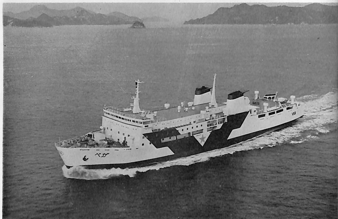
ベガ (自動車航送旅客船) 船主 新東日本フェリー株式会社 造船所 内海造船・瀬戸田工場 総噸数 6,702.25噸 純噸数 3,128.40噸 沿海 載貨重量 2,323噸 全長 136.58m 長(垂) 127.00m 幅(型) 21.20 m 深(型) 7.80m 吃水 5.70m 満載排水量 7,765噸 全通船楼二層甲板型 主機 NKK-16PC2-5V型デ ィーゼル機関1基 出力 2 \times 8,020 PS \times 511/210 RPM 燃料消費量 69.10t/d 航続距離 1,865海里 速力 21.50 ノット 発電機 AC 450V, 60Hz \times 3 基 車両搭載台数 8 1 / 2 積トラック 75台, 乗用車 60台, 旅客計 712名 清 水倉 327.94m 3 燃料油倉 289.59m 3 乗員 60名 工期 48-4-17, 48-8-31, 48-12-1
