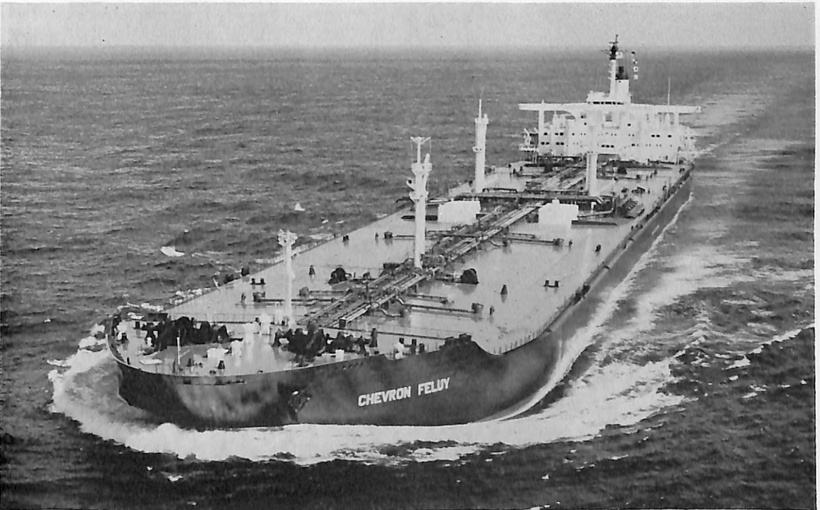
CHEVRON FELUY (油槽船) 船主 Chevron Tranaport Corporation (リベリア) 造船所 三菱重工業・ 長崎造船所 総噸数 118,192.11噸 純噸数 100,263噸 遠洋 船級 AB 載貨重量 264,191噸 全長 338.629 m 長(垂) 320.00m 幅(型) 53.60m 深(型) 26.40m 吃水 67'-5 3 / 4 " 船首樓付平甲板船 主機 三菱2段減速装 置付船用タービン×1 出力 34,000PS×90RPM 燃料消費量 165t/d 航続距離 24,000 海里 速力 15.3ノット 汽罐 三菱CE, V 2M-8W 発電機 AC450V, 1,500kg/cm 2 ×2 貨油倉 320,552.1m 3 清水倉 372.5m 3 燃料 油倉 12,296.6m 3 乗員 52名外8名 工期 48-4-5, 48-7-19, 48-11-8 同型船 Paul L. Fahrnet
