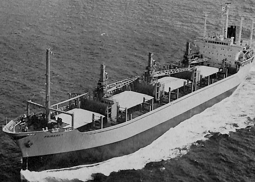
FAIREAST (自動車兼ばら積貨物船) 船主 Three Stars Chipping Ltd. (リベリア) 造船所 林兼造船株式会社 社長崎造船所 総噸数 9,960.55噸 純噸数 6,258噸 遠洋 船級 AB 載貨重量 16,174.57噸 全長 152.76m 長(垂) 140.00m 幅(型) 22.20m 深(型) 8.90m 吃水 8.961m 満載排水量 21,836.80噸 凹甲板型 主機 IH I スルザー 6 RD68型ディーゼル機関1基 出力 7,200PS×144.8RPM 燃料消費量 27.13t/d 航続距離 12,000海里 速力 14.8ノット 汽罐 コクラン缶1000kg/h×1台 発電機 AC 445V×330KVA×3台 貨物倉 (ベール)19,789.49m 3 (グリーン)21,009.44m 3 貨油倉 自動車積載量(ブルーバード型)1,202台清水倉 531.95m 3 燃料油倉 A 168.51m 3 C 1,052.49m 3 乗員 39名 工期 48-3-3, 48-7-17, 48-10-26 設備 吊下げ 式および取外し式ポンツーン型自動車甲板装備
