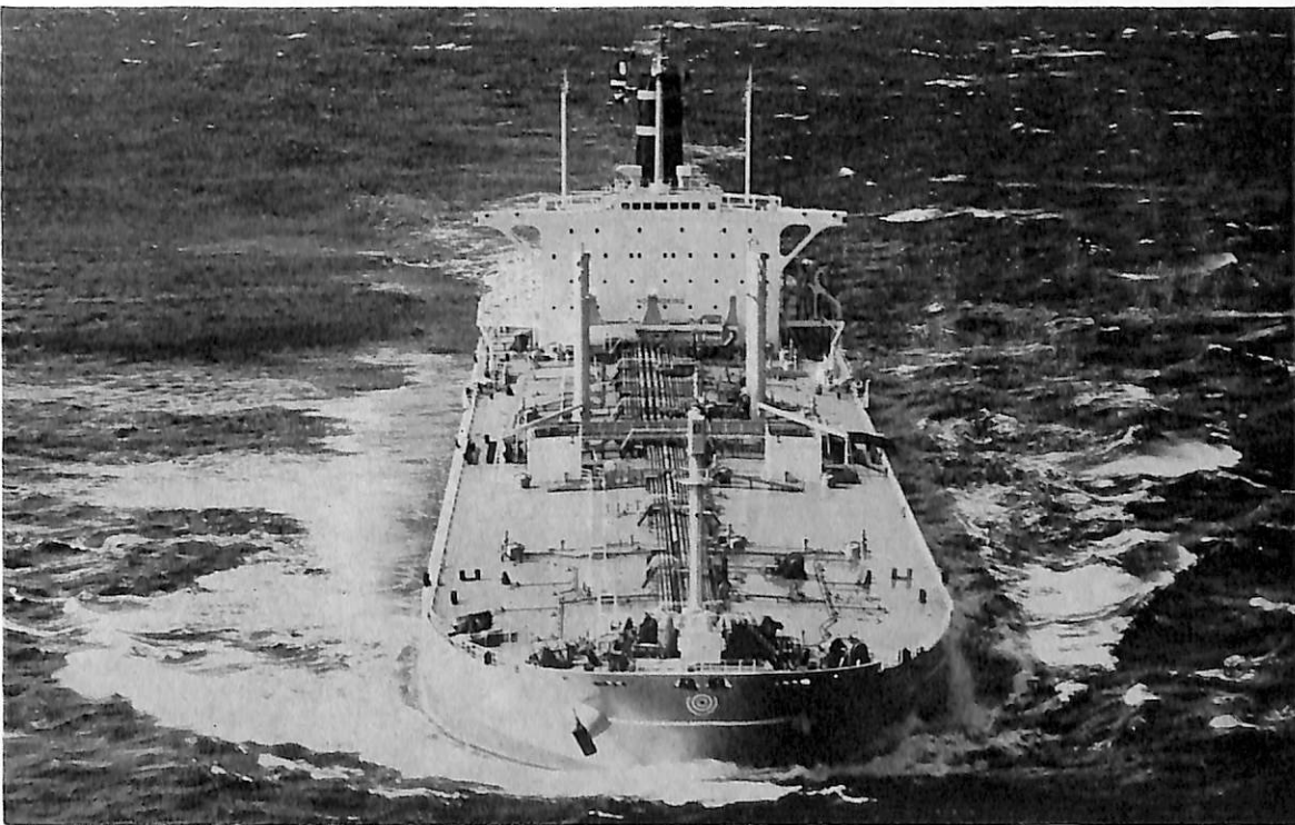
NATAJI SUBMAS ROSE (油槽船) 船主 The Shipping Corporation of India Ltd. (印度) 造船所 三菱重工業・神戸造船所 総噸数 51,525.96噸 純噸数 36,702.91噸 遠洋 船級 AB 載貨重量 87,980噸 全長 237.614m 長(垂) 226.00m 幅(型) 39.40m 深(型) 18.70m 吃水 13.948m 満載排水量 106,245噸 平甲板型 主機 三菱スルザー7 RND90型ディーゼル機関1基 出力 17,250PS×116RPM 航続距離 24,000海里 速力 15.3ノット 汽罐 三菱ダブルエバポレーション型32t/h×2 発電機 1,000KVA, 450V×3 貨油倉105,816.6m 3 乗員 69名 工期 48-3-26, 48-7-11, 48-11-30 特徴 Indian MOT規則の適用
