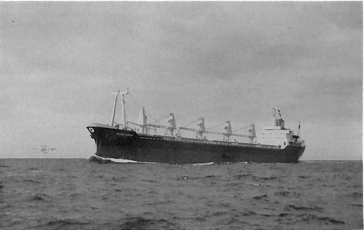
GOLDEN KIMISIS (ばら積貨物船) 船主 Golden Notly Steamship, Inc.(ギリシャ) 造船所 函館ドック株式会社室蘭製作所 総噸数 16,438.79噸 純噸数 11,371噸 遠洋 船級 AB 載貨重量 28,879噸 全長 180.80m 長(垂) 170.00m 幅(型) 23.10m 深(型) 14.50m 吃水 34'-11 1/2" 満載排水量 35,195噸 凹型甲板船 主機 IHI-スルザー 6 RND76型ディーゼル機関1基 出力 10,800BHP×117.8RPM 燃料消費量 40.63t/d 航続距離 22,000海里 速力 15.0ノット 汽罐 AALBORG AQ-3型 1,200kg/h×1 発電機 AC450V×387.5KVA×2 貨物倉(ベール) 1,196,881ft 3 (グリーン) 1,342,932ft 3 清水倉 7,386ft 3 燃料油倉 105,097ft 3 乗員 37名 工期 48-4-14, 48-7-31, 48-11-1 同型船 GOLDEN EVAGELISTRA
