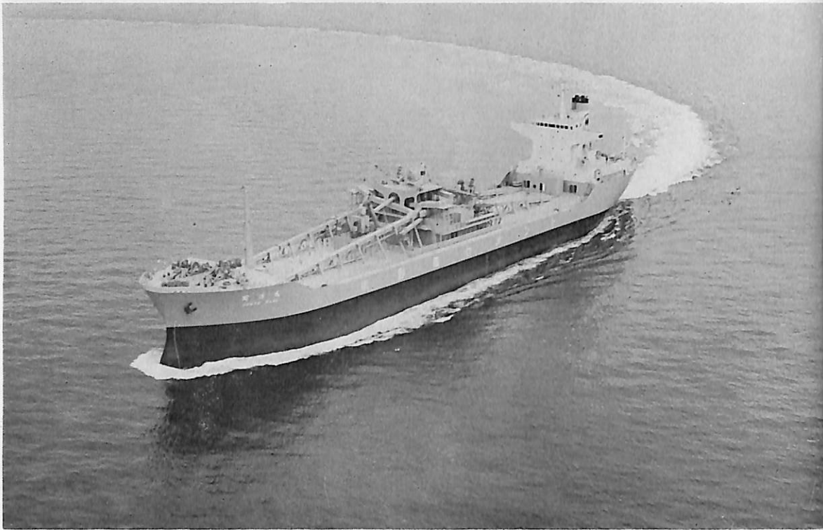
周洋丸 (セメント運搬船) 船主 東海運輸株式会社 造船所 常石造船株式会社 総噸数 13,246.23噸 純噸数 7,467.79噸 沿海 船級 NK 載貨重量 21,805噸 全長 164.08m 長(垂)155.00m 幅(型) 24.00m 深(型) 12.50m 吃水 9.343m 満水排水量 28,697噸 凹甲板型 主機 I H I - 12 P C - 2 V 型 ディーゼル機関 2基(2機1軸) 出力 2×5,400/10,640PS×502/130.4RPM 燃料消費量 40.6t/d 航続距離 3,400海里 速力 15.2ノット 汽罐 ウレイトン式 7kg/cm 2 G×1,250kg/H 貨物倉 セメント容積 18,266.0m 3 清水倉 133.1m 3 燃料油倉 FO 426.1m 3 DO 115.8m 3 乗員 24名 工期 48-2-10, 48-5-1, 48-9-6
