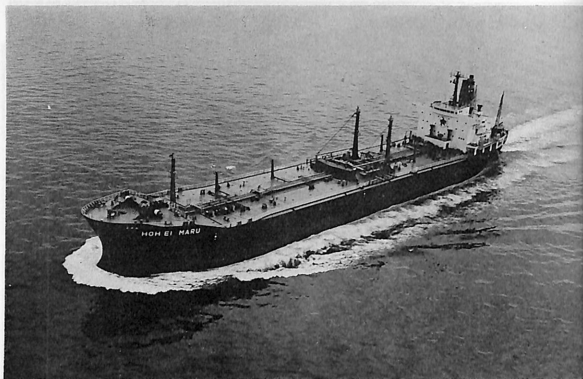
宝 栄 丸 (油槽船) 船主 宝洋海運産業株式会社 造船所 常石造船株式会社 総噸数 20,793.08噸 純噸数 12,919.08噸 近海 船級 NK 載貨重量 36,408噸 全長 189.00m 長(垂)180.00 m 幅(型) 27.000m 深(型) 14.950M 吃水 11.024m 満載排水量 45,141噸 船首楼付平甲板型 主機 三井B &W 6 K84 E F型ディーゼル機関1基 出力 13,200PS×108RPM 燃料消費量 49.6t/d 航続距離 11,700海里 速力 15.5ノット 汽罐 32,000kg/h×16kg/cm 2 発電機 610KW×2 燃料油倉 44,774.5m 3 清水倉 297.1m 3 乗 員 30名 工期 48-5-10, 48-7-17, 48-10-31
