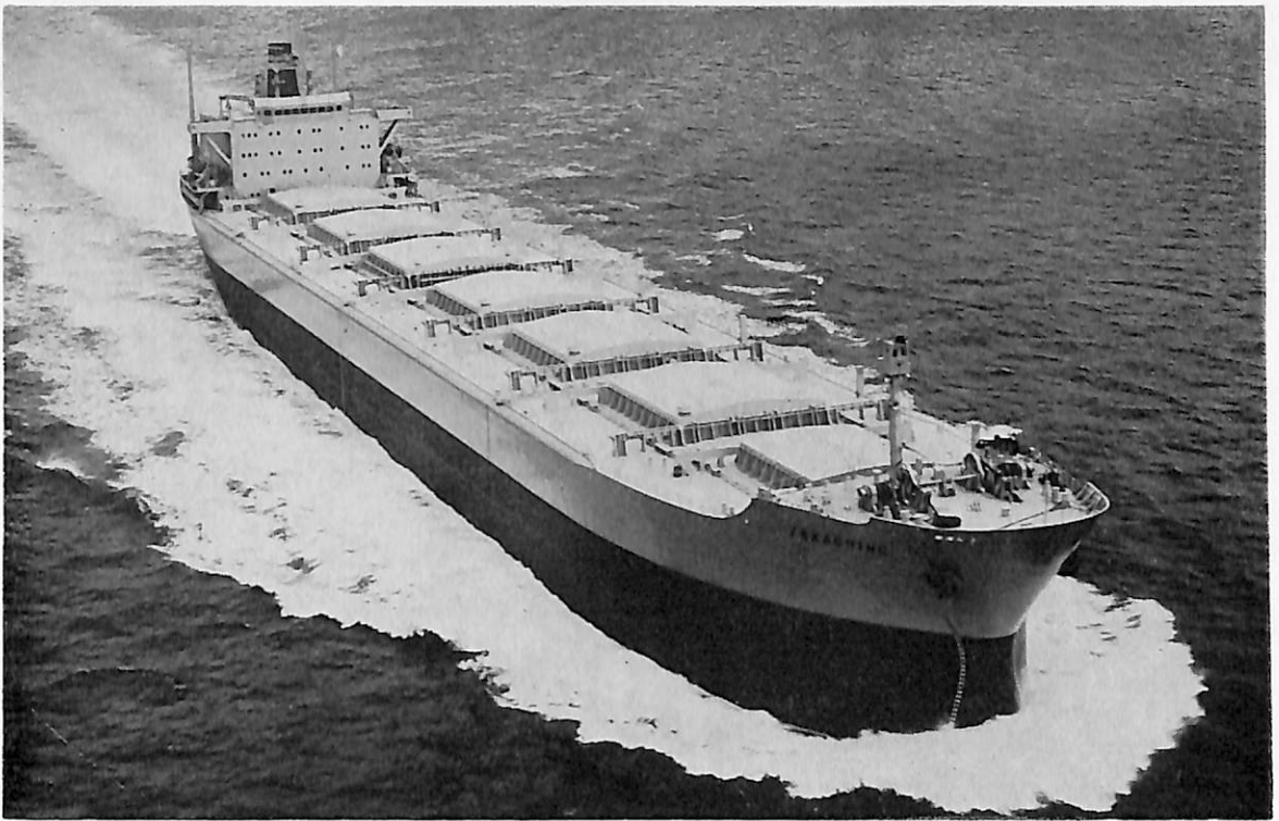
TAKACHIHO (ばら積貨物船) 船主 Wilh. wilhelmsen系列会社9社(ノルウェー) 造船所 三菱重工業・神戸造船所 総噸数 36,264.61噸 純噸数 23,302.43噸 遠洋 船級 NV 載貨重量 63,533噸 全長 224.00m 長(垂) 211.28m 幅(型) 31.80m 深(型) 18.35m 吃水 13.345m 満載排水量 75,315Lt 船首楼付平甲板船 主機 三菱スルザー 7 RND76型ディーゼル機関1基 出力 12,600PS×118RPM 燃料消費量 46.2t/d 航続距離 22,000海里 速力 14.6ノット 汽罐 コ克蘭 1,800kg/h×1,排エコ 1,800kg/h×1 発電機 AC450V 60Hz, 400KW×3 貨物倉(グリーン) 76,315.0m 3 清水倉 543.8m 3 燃料油倉 3,505.1m 3 乗員 35名 工期 48-3-14, 48-8-22, 48-11-27 設備 EO取得船
