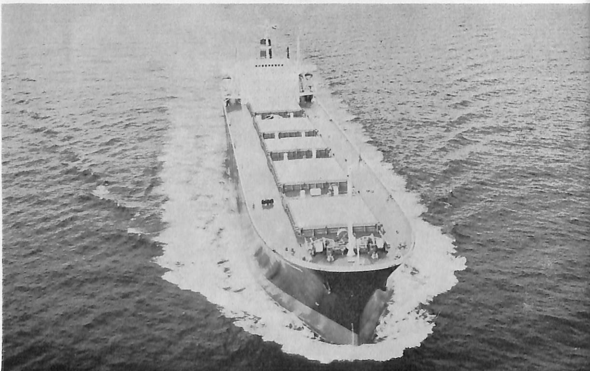
BUNGA MELAWIS (チップ運搬船) 船主 Malaysian International Shipping Corporation Berhad (マレーシア) 造船所 住友重機械工業・浦賀造船所 総噸数 32,321.03噸 船級 LR 載貨重量 32,716噸 長(垂) 188.00m 幅(型) 29.40m 深(型) 20.80m 吃水 9.70m 主機 住友スルザー 7 R D 76型ディーゼル機関 1基 出力 11,200PS×122RPM 速力 16.798ノット 工期 48-2-19, 48-5-30, 48-9-28
