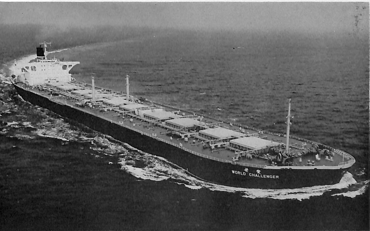
WORLD CHALLENGER (鉱・油兼用船) 船主 Liberian Golaxie Transports Inc. (リベリア) 造船所 日立造船・因島工場 総噸数 85,737.28噸 純噸数 69,765噸 遠洋 船級 AB 載貨重量 164,338噸 全長 313.90m 長(垂) 302.00m 幅(型) 44.20m 深(型) 24.20m 吃水 17.1025m 満載排水量 194,017噸 平甲板型 主機 日立B & W 12 K84 E F型ディーゼル機関1基 出力 28,100PS×110RPM 燃料消費量 103.2t/d 航続距離 23,000海里 速力 16.0ノット 汽罐 日立-2胴水管式 発電機 900KW×AC450V×1, 980KW×AC450V×1 貨物倉 88,213.90m 3 貨油倉 204,637.95m 3 清水倉 662.80m 3 燃料油倉 6,462.72m 3 乗員 38名外10名 工期 48-4-10, 48-8-1, 48-11-14
