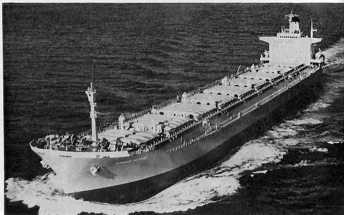
KONKAR VICTORY (ばら積貨物船) 船主 Konkar Victory Corporation (リベリア) 造船所 三井造船・玉野造船所 総噸数 39,219.13噸 載貨重量 76,764噸 全長 259.528m 長(垂) 249.00m 幅(型) 32.156m 深(型) 18.593m 吃水 13.64m 主機 三井B&W 7 K84EF型ディーゼル機関1基 船級 AB 出力 17,500PS×114RPM 貨物倉 91,449.8m 3 速力 17.13ノット 乗員 42名 竣工 48-12-5 設備: 居住区には空調装置, サウナバス付スポーツ・ルーム, プール設置
