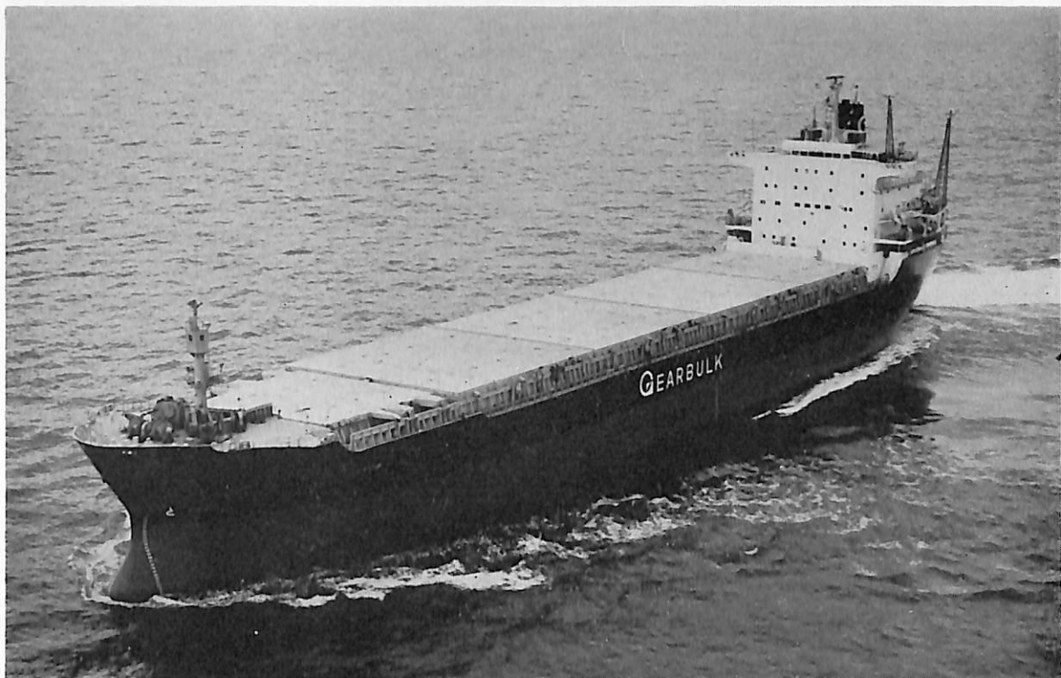
KIWI ARROW (ばら積貨物船) 船主 Kristian Gerhard Jebsen Skipsrederi (ノルウェー) 造船所 三井造船・藤永田造船所 総噸数 24,999.90噸 純噸数 12,993.10噸 遠洋 船級 NV 載貨重量 38,613噸 全長 182.00m 長(垂) 174.00m 幅(型) 29.00m 深(型) 16.10m 吃水 11.589m 満載排水量 49,707噸 凹甲板船 主機 三井B&W DE 7 K74E F型ディーゼル機関1基 出力 11,900BHP×120RPM 燃料消費量 A 3.15t/d C 48.07t/d 航続距離 15,000海里 速力 14.5ノット 汽罐 サンロッド CPDB-15 発電機 450V, 812.5KVA × 1,000BHP×3 貨物倉(ランバー) 40,745m 3 (グリーン) 41,684m 3 清水倉 283.5m 3 燃料油倉 2,321.4m 3 乗員 37名 工期 48-6-3, 48-9-27, 49-1-16 設備 2×25t ガントリークレーン設置
