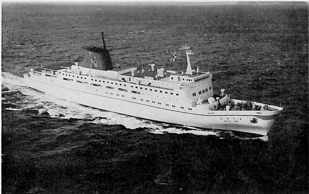
美々津丸 (自動車航送旅客船) 船主 日本カーフェリー株式会社 造船所 内海造船・瀬戸田工場 総噸数 9,551.62噸 載貨重量 2,594.8噸 全長 159.50m 長(垂) 148.00m 幅(型) 21.50m 深(型) 8.80m 吃 水 6.20m 主機 三菱MAN-V9V 52/55型ディーゼル機関×2 出力 2×18,000PS×430-210RPM 航続距離 2,210海里 速力 25.6ノット 旅客 貴賓室 4名,特等室 84名,一等室 188名,ツーリスト客室(含,予備) 740名, 計 1,016名,乗員 82名 車輛搭載能力 トラック(8t積) 62台,(4t積) 22台,乗用車 120台 航路 川崎-日向, 工期 48-5-22, 48-11-12, 49-2-15
