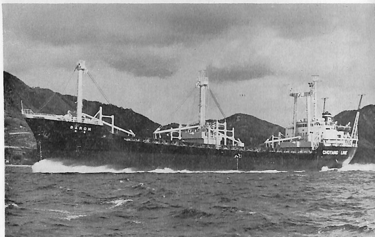
BARON (貨物船) 船主 Crimson Navigation Co., S.A. (パナマ) 造船所 今治造船株式会社 総噸数 3,939.95噸 純噸数 2,822.74噸 遠洋 船級 NK 載貨重量 6,544.54噸 全長 105.57m 長(垂) 98.60 m 幅(型) 16.33m 深(型) 8.40m 吃水 6.821m 満載排水量 8,566.00噸 ウエル甲板型 主機 阪神内燃機 6L U50A型ディーゼル機関1基 出力 3,230PS×218RPM 燃料消費量 11.86t/d 航続距離 11,590海里 速力 12.7ノット 発電機 165KVA×2 貨物倉(ベール) 8,000.21m 3 (グリーン) 8,421.48m 3 清水倉 414.68m 3 燃料 油倉 585.73m 3 乗員 28名 工期 48-8-3, 48-11-4, 48-12-14
