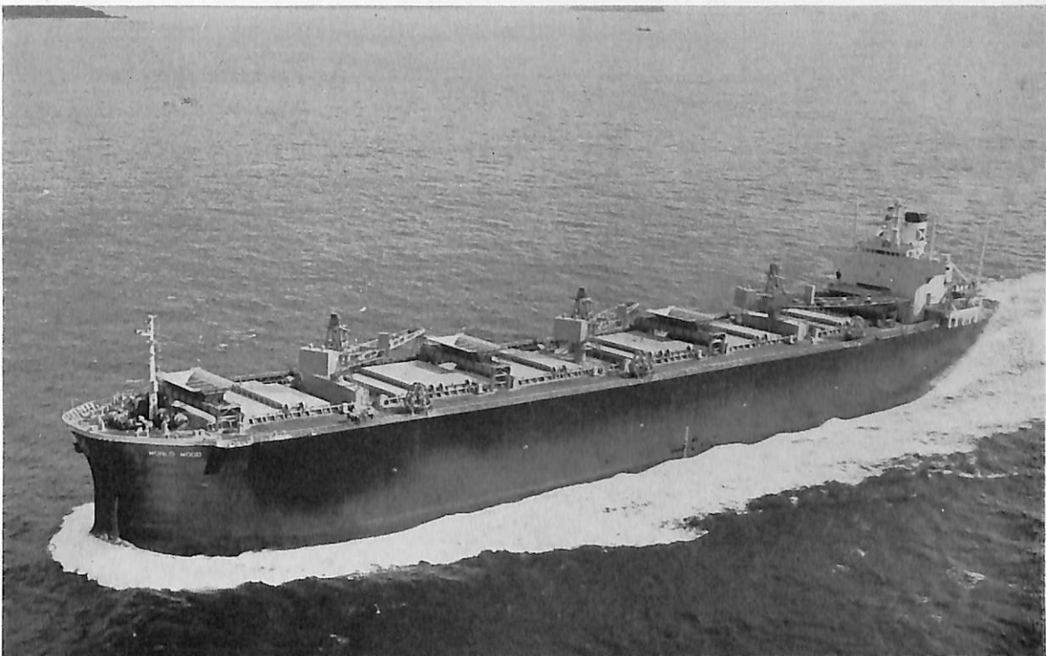
WORLD WOOD (チップ運搬船) 船主 Eastern Pearl Transports Inc. (リベリア) 造船所 林兼造船・長崎造船所 総噸数 36,966.25噸 純噸数 27,906噸 遠洋 船級 AB 載貨重量 46,599.82噸 全長 205.74m 長(垂) 196.50m 幅(型) 30.48m 深(型) 21.30m 吃水 11.3495m 満載排水量 58,620.04噸 平甲板船 主機 三菱スルザー 7 RND76型ディーゼル機関1基 出力 11,900PS×115.5RPM 燃料消費量 43.7t/d 航続距離 14,000海里 速力 14.8ノット 汽罐 コクラン缶 1,200kg/h×1台 発電機 AC 445V×580KW×3台 貨物倉(グリーン) 88,977.56m 3 清水倉 512.64m 3 燃料油倉 A 306.20m 3 C 2,209.66m 3 乗員 45名 工期 48-7-5, 48-11-15, 49-1-31 設備 チップ揚降装置: デッキクレーン 10.5t×3 ベルトコンベア×1 ホッパ×4
