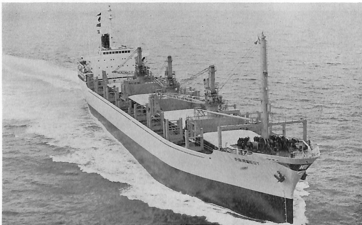
FAIRWEST (自動車兼ばら積貨物船) 船主 Helindas Navigation Co., Ltd. (リベリア) 造船所 林兼造船・長 崎造船所 総噸数 9,960.55噸 純噸数 6,258噸 遠洋 船級 AB 載貨重量 16,238.07噸 全長 152.76m 長(垂) 140.00m 幅(型) 22.20m 深(型) 12.00m 吃水 8.961m 満載排水量 21,836.80噸 凹甲板船 主機 IHI-スル ザー6RD68型ディーゼル機関1基 出力 7,200PS×144.8RPM 燃料消費量 26.6t/d 航続距離 120,000海里 速力 14.80ノット 汽罐 コ克蘭コンポジット缶 1,000kg/h×1台 発電機 330KVA×3 貨物倉(ベール) 19,789.49m 3 (グレーン) 21,009.44m 3 清水倉 531.95m 3 燃料油倉 A 168.51m 3 , C 1,052.49m 3 乗員 39名 工期 48-7-17, 48-10-13, 49-2-6 吊下げ式自動車甲板装備. 積載車 計 1,202台
