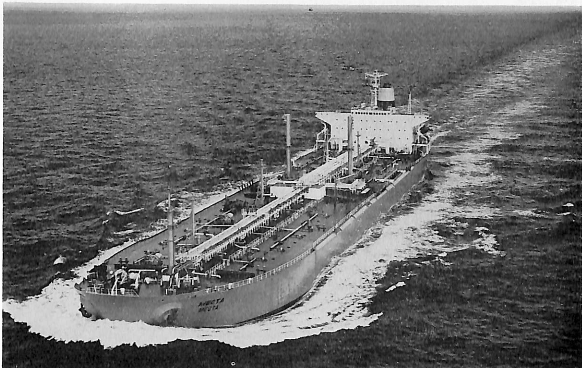
MESTA (油槽船) 船主 Koraboimpex (ブルガリア) 造船所 笠戸ドック株式会社 総噸数 46,773.55噸 純噸数 27,805.78噸 遠洋 船級 LR 載貨重量 75,275噸 全長 237.00m 長(垂) 225.00 m 幅(型) 37.20m 深(型) 18.60m 吃水 12.917m 満載排水量 90,554噸 平甲板型 主機 IHI-スルザー 7 R ND90型ディーゼル機関1基 出力 18,270PS×117.8RPM 燃料消費量 72噸/d 航続距離 14,800海里 速力 15.5ノット 汽罐 2 胴水管 25kg/h×16kg/cm 2 ×2 排ガス 2.5噸/h×7kg/cm 2 ×1 発電機 660KW×3 貨油倉 95,992.44m 3 清水倉 411.32m 3 燃料油倉 F 3,535.34m 3 D 240.88m 3 乗員 38名 工期 48-5-10, 48-9-28 49-1-12 設備 イナートガス装備, セルフストリップング装備
