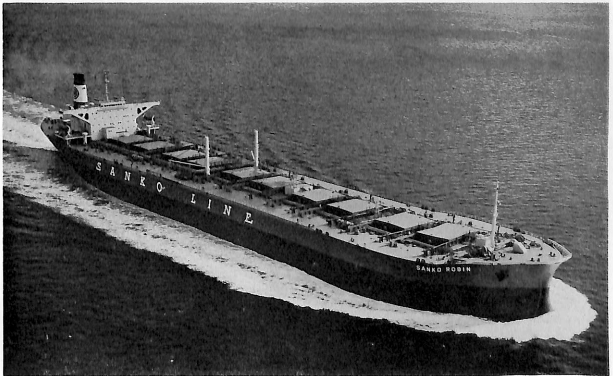
SANKO ROBIN (鉦油兼用船) 船主 Overseas Transport Co., (シンガポール) 造船所 日立造船・因島工場 総噸数 89,496.05噸 純噸数 62,519.08噸 遠洋 船級 NK 載貨重量 162,438噸 全長 300.00m長(垂) 289.00 m 幅(型) 48.00m 深(型) 23.00m 吃水 17.134m 満載排水量 193,596噸 平甲板船 主機 日立B&W12K84 EF型ディーゼル機関1基 出力 28,100PS×110RPM 燃料消費量 103.2t/d 航続距離 26,900海里 速力 16.05ノット 汽罐 日立2胴水管ボイラー 貨物倉 92,814.14m 3 貨油倉 202,307.78m 3 清水倉 1,000.72m 3 燃料油倉 7,839.39m 3 乗員 40名 工期 48-4-5, 48-8-31, 48-11-29
