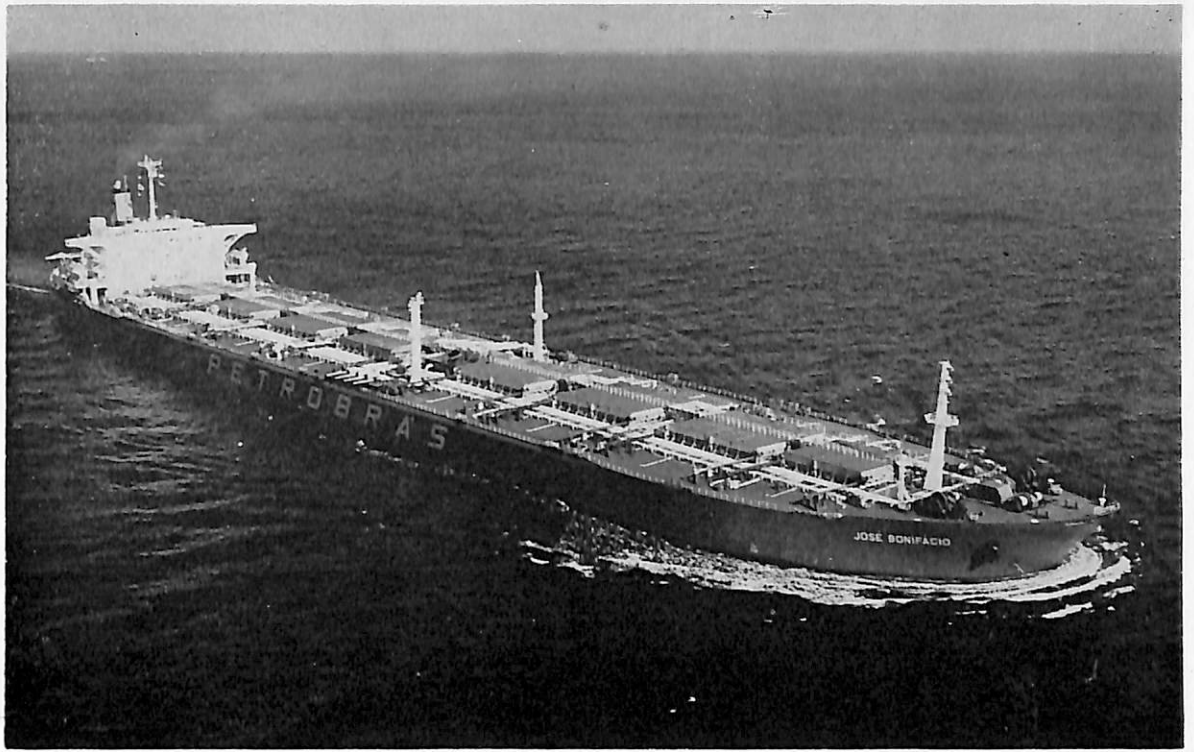
JOSE BONIFACIO (鉦油兼用船) 船主 Petroleo Brasileiro S.A. (ブラジル) 造船所 石川島播磨重工業・呉造船所 総噸数 126,759.83噸 純噸数 104,101噸 遠洋 船級 AB 載貨重量 270,358噸 全長 337.132 m 長(垂) 320.00m 幅(型) 54.50m 深(型) 28.00m 吃水 21.076m 平甲板船 主機 IHI-タービン1基 出力 36,000PS×80RPM 燃料消費量 174.79t/d 航続距離 35,990海里 速力 15.98ノット 汽罐 IHI-MONO-W ALL型×2 発電機 AC1,800KW×60Hz×450V×1,800rpm 貨物倉(クレーン) 151,443.9m 3 貨油倉 328,000.7m 3 清水倉 1,056.2m 3 燃料油倉 17,988.9m 3 乗員 36名, 外 8名 工期 48-5-29, 48-9-7, 49-1-24
