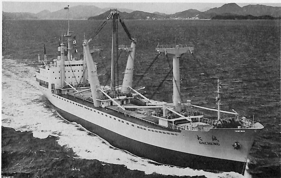
大 城 (貨物船) 船主 China National Machinery Import & Export Corporation (P. R. of China) 造船所 日立造船・向島工場 総噸数 10,715.31噸 純噸数 5,782.3噸 遠洋 船級 LR 載貨重量 14,522噸 全長 154.90m 長(垂) 145.00m 幅(型) 22.00m 深(型) 12.00m 吃水 9.061m 満載排水量 20,613噸 船尾 樓付凹甲板船 主機 日立B&W 6 K 62E F 型ディーゼル機関1基 出力 7,600PS×140RPM 燃料消費量 30.7 t/d 航続距離 14,600海里 速力 15.6ノット 汽罐 日立造船フレミングNo45型ボイラ×1 発電機 525KVA, A C400V, 50Hz×750rpm×3 貨物倉(ベール) 19,462m 3 (グリーン) 20,574.9m 3 清水倉 366.2m 3 燃料油倉 1,225.2m 3 乗員 55名 工期 48-6-25, 48-9-19, 48-12-21
