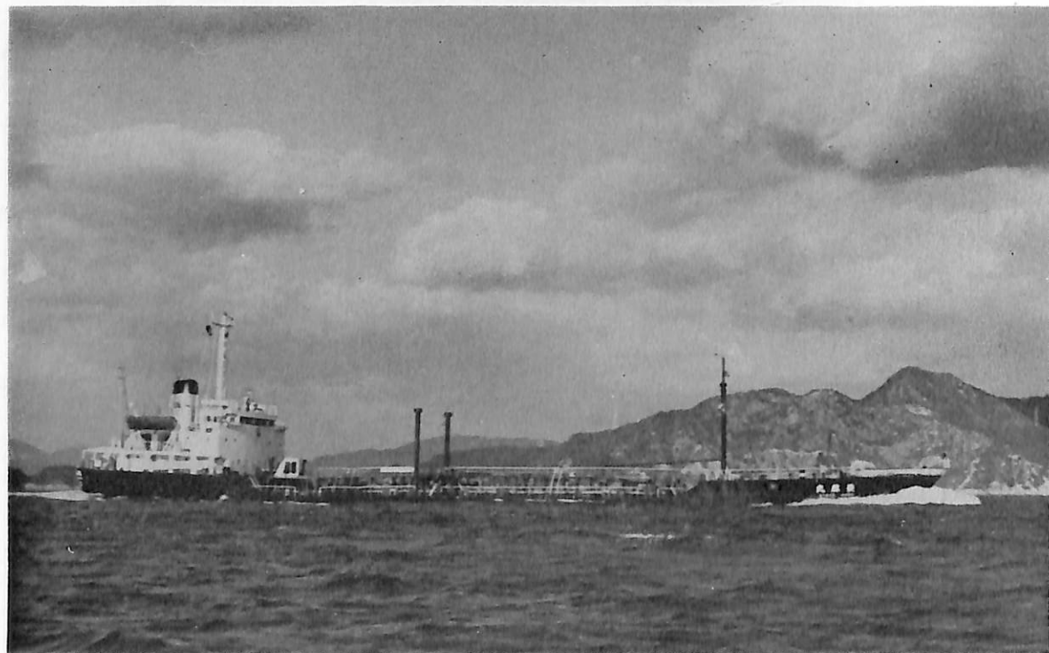
菱 藤 丸 (油槽船) 船主 船舶整備公団・松藤商事合資会社 造船所 今治造船株式会社 総噸数 1,598.25噸 純噸数 1,151.79噸 沿海 船級 NK 載貨重量 3,789.32噸 全長 88.40m 長(垂) 82.00m 幅(型) 13.40m 深(型) 6.50m 吃水 5.792m 満載排水量 4,893.00噸 ウェル甲板型 主機 ダイハツ6DSM -26型ディーゼル機関1基 出力 1,105PS×710RPM 燃料消費量 8.9t/d 航続距離 2,800海里 速力 12.14 ノット 汽罐 クレイトン型RHDB-30, 470kg/h, 7.0kg/cm 2 発電機 140KVA×2 37.5KVA×1 貨油倉 4,507 m 3 清水倉 63m 3 燃料油倉 114m 3 乗員 13名 工期 48-7-11, 48-10-25, 48-12-15
