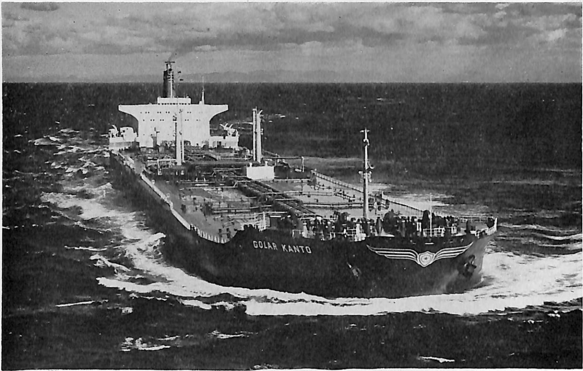
GOLAR KANTO (油槽船) 船主 Ocean Oil Sanchu, Inc. (リベリア) 造船所 川崎重工・坂出工場 総噸数 98,885噸 純噸数 80,903噸 遠洋 船級 NV 載貨重量 215,714Lt 全長 327.00m 長(垂) 313.00m 幅(型) 48.20m 深(型) 25.20m 吃水 19.597m 船首樓付平甲板 主機 KAWASAKI UR-315 型船用タービ ン1基 出力 28,000PS×88RPM 燃料消費量 122.5t/d 航続距離 18,100海里 速力 15.52ノット 汽罐 KA WASAKI UFR 87/77型 発電機 タービン2×1,280KW, 1,600KVA A. C. 450V ディーゼル 1×560KW, 700KVA A. C. 450V 貨油倉 267,300m 3 燃料油倉 6,300m 3 乗員 41名 工期 47-7-17, 47-10-12, 48-2-5
