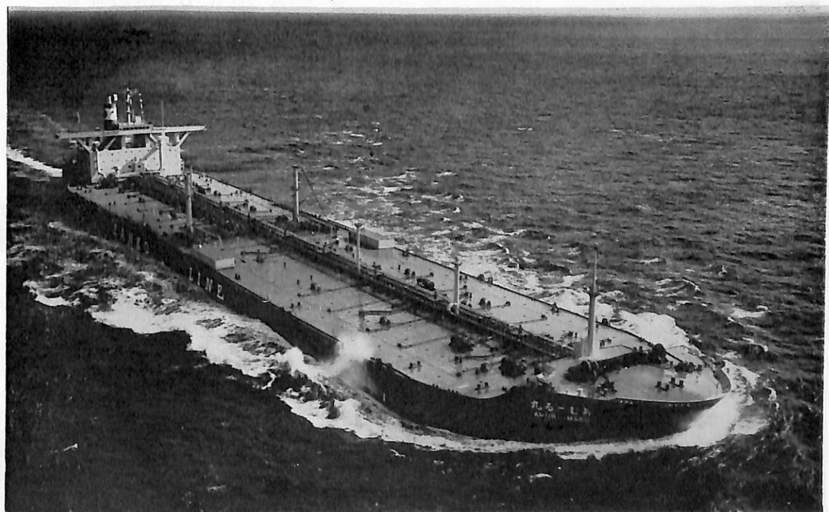
あ む る 丸 (油槽船) 船主 三光汽船株式会社 造船所 三菱重工業・長崎造船所 総噸数 117,572.30噸 純噸数 88,418.11噸 遠洋 船級 NK 載貨重量 237,020噸 全長 321.82 m 長(垂) 304.00 m 幅(型) 52.40 m 深(型) 25.70 m 吃水 19.8475 m 船首楼付平甲板船 主機 三菱船用パッケージド減速装置付タービン×1 出力 34,000PS×90RPM 航続距離 17,000海里 速力 15.8ノット 汽罐 三菱CEV2M-8W型×2 発電機 1,400KW, AC 450V, 1800rpm 貨油倉 289,150.7m 3 清水倉 760.1m 3 燃料油倉 8,586.3m 3 乗員 39名 工期 48-6-21, 48-10-16, 49-1-31 同型船 円光丸
