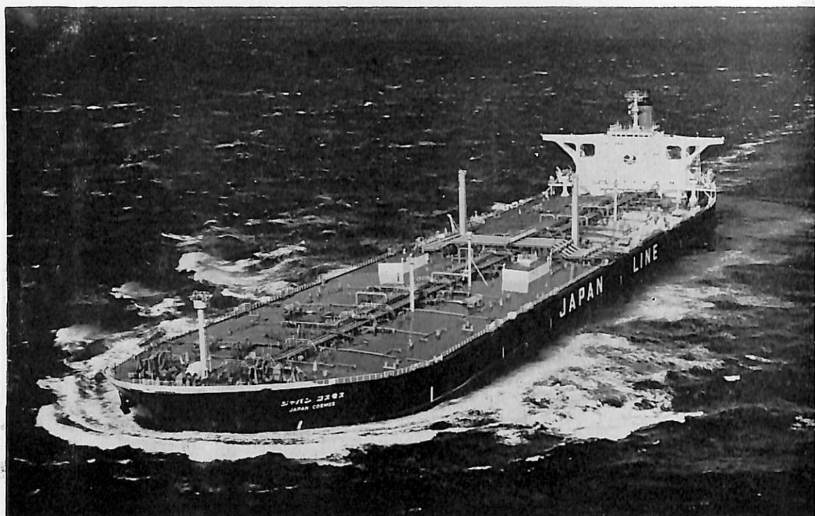
ジャパンコスモス (油槽船) 船主 ジャパンライン株式会社 造船所 三井造船・千葉造船所 総噸数 135,521.06噸 純噸数 101,796.74噸 遠洋 船級 NK 載貨重量 273,225噸 全長 331.50m 長(垂)318.00 m 幅(型) 56.00m 深(型) 26.40m 吃水 20.58m 満載排水量 311,109噸 平甲板型 主機 IHI クロスコンバ ウンド型衝動式二段減速装置付タービン 出力 36,000SHP×85RPM 燃料消費量 181t/d 航続距離 17,500海 里 速力 15.96ノット 汽罐 三井FW“MSD”型×2基 発電機 1,900KW×1台 950KW×2台 貨油倉 328,065.5 m 3 清水倉 652.7m 3 燃料油倉 9,110.9m 3 乗員 36名 工期 48-4-20, 48-10-18, 49-1-31 設備 主機自動化操縦 (MO)
