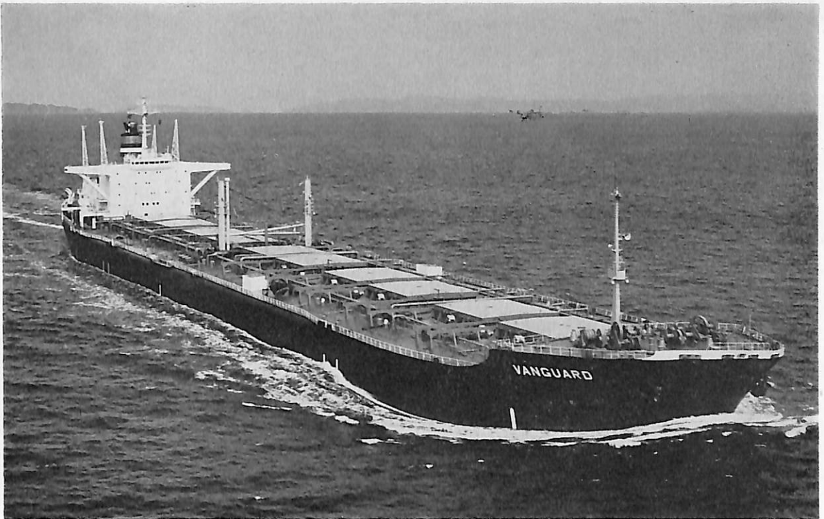
VANGUARD (鉱油兼用船) 船主 Maxitanks Shipping Inc. (パナマ) 造船所 川崎重工・神戸工場 総噸数 77,000噸 遠洋 船級 LR 載貨重量 157,182噸 全長 289.00m 長(垂) 275.00m 幅(型) 44.00m 深 (型) 24.20m 吃水 17.900m 船首楼付平甲板 主機 川崎M. A. N. K 7 SZ 105/180型ディーゼル機関1基 出 力 25,200PS×102RPM 航続距離 19,200海里 速力 15.5ノット 汽罐 1×Oil Fired boiler, 1×Exhaust Gas boiler 発電機 2×1,287.5KVA 450V貨物倉 Ore 87,000m 3 Cargo Oil 196,100m 3 燃料油倉 5,400m 3 乗員 37名 工期 48-9-12, 48-12-7, 49-2-27
