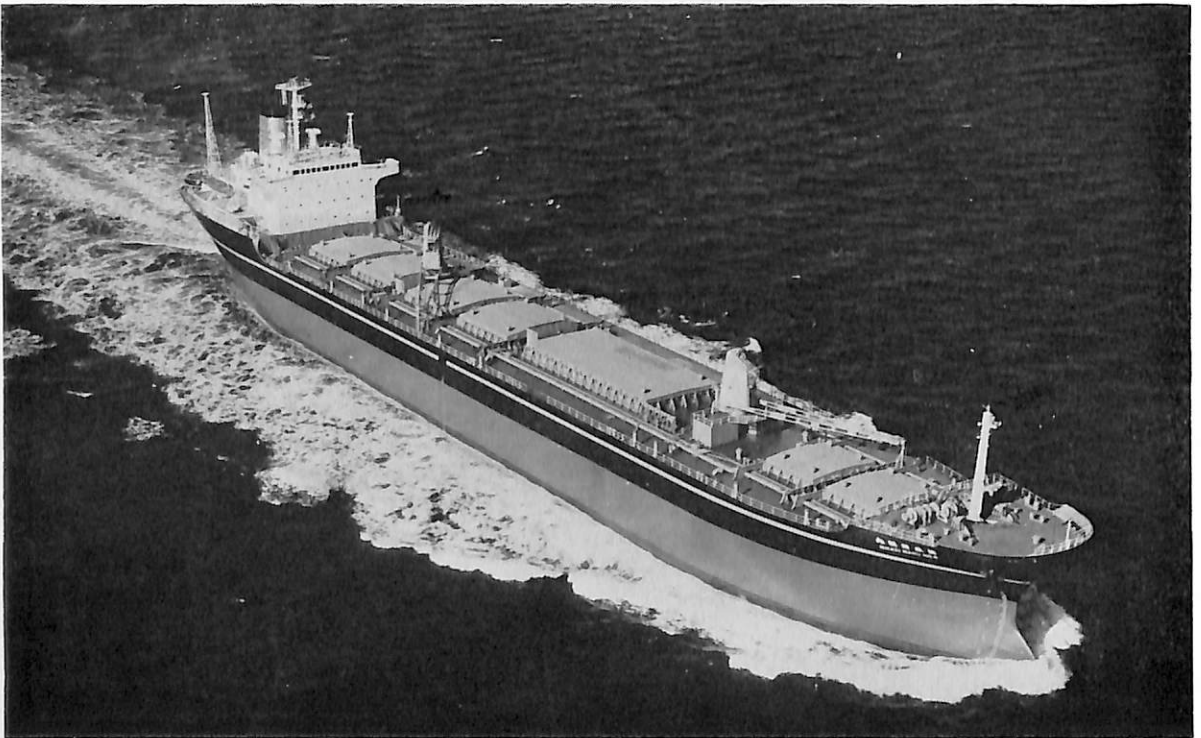
第五日輕丸 (ホーキサイト及び赤泥運搬船) 船主 山下新日本汽船株式会社・玉井商船株式会社 造船所 今治造船・丸亀工場 総噸数 20,378.73噸 純噸数 10,205.96噸 遠洋 船級 NK 載貨重量 34,419.62噸 全長 185.23m 長(垂) 172.00m 幅(型) 26.00m 深(型) 15.70m 吃水 11.224m 満載排水量 42,712.00噸 ウエル甲板型 主機 三菱スルザー7RND68型ディーゼル機関1基 出力 9,817PS×142RPM 燃料消費量 36.77t/d 航続距離 14,340海里 速力 14.2ノット 発電機 625KVA×3 貨物倉(グレーン) 37,116m 3 清水倉 543.03m 3 燃料油倉 2,183.84m 3 乗員 30名 工期 48-6-1, 48-11-14, 49-1-27 設備 赤泥の海面下排出用として専用ポンプ(1600m 3 /h)ベルマウス付のゴムホース及び油圧駆動ホース各2組を有する。
