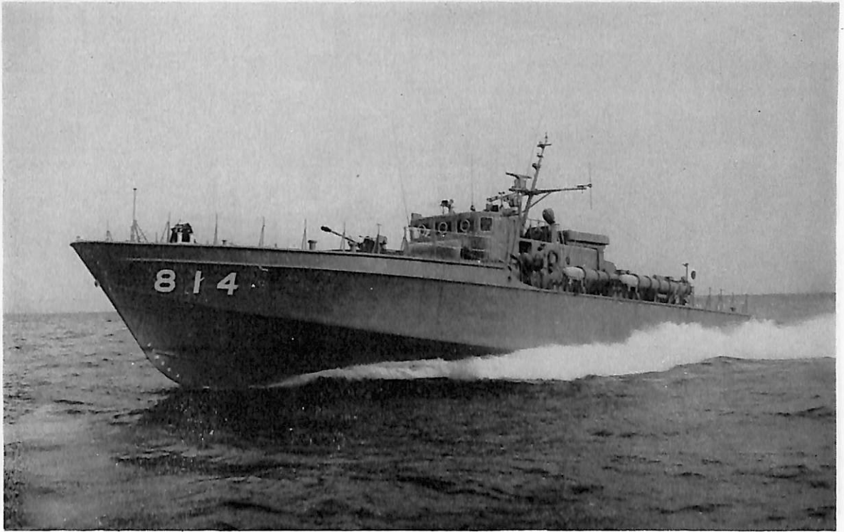
魚雷艇 14号 船主 防衛庁 造船所 三菱重工業・下関造船所 基準排水量 100噸 全長 35.10m 幅(型) 9.20m 深(型) 3.75m 吃水 1.20m 主機 24WZ-31MC型ディーゼル 機関2基2軸 IM300型ガスタービン機関2基1軸 計3軸 出力 合計 11,000PS 速力 40km 乗員 26名 工期 48-3-23, 48-7-10, 49-2-15 兵装 40mm単装機関砲 2, 53cm魚雷発射管 4, 軽合金製魚雷艇 11号の4番艇
