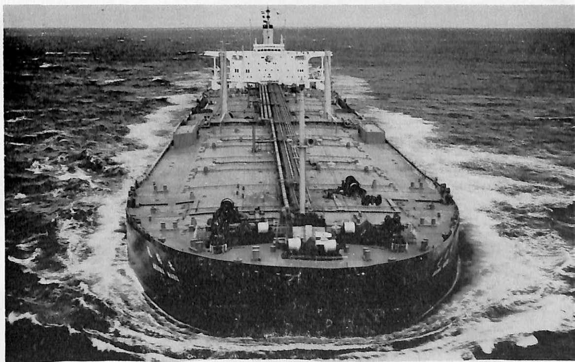
赤間丸 (油槽船) 船主 出光タンカー株式会社 造船所 石川島播磨重工業・呉造船所 総噸数 136,011.31噸 純噸数 97,948.81噸 遠洋 船級 NK 載貨重量 257,099噸 全長 337.058m 長(舳) 320.00m 幅(型) 54.50m 深(型) 27.00m 吃水 19.90m 平甲板船 主機 IHIクロスコンパウンドタービン×1 出力 36,000PS×80RPM 燃料消費量 176.7t/d 航続距離 32,300海里 速力 16.30ノット 汽罐 IHI-MDMFWボイラー×2 貨油倉 311,805.95m 3 清水倉 1,050.36m 3 燃料油倉 16,833.25m 3 乗員 45名 工期 48-6-25, 48-10-29, 49-2-22 設備 データブリッジ, 航海衛星受信装置, ドブラーソナー
