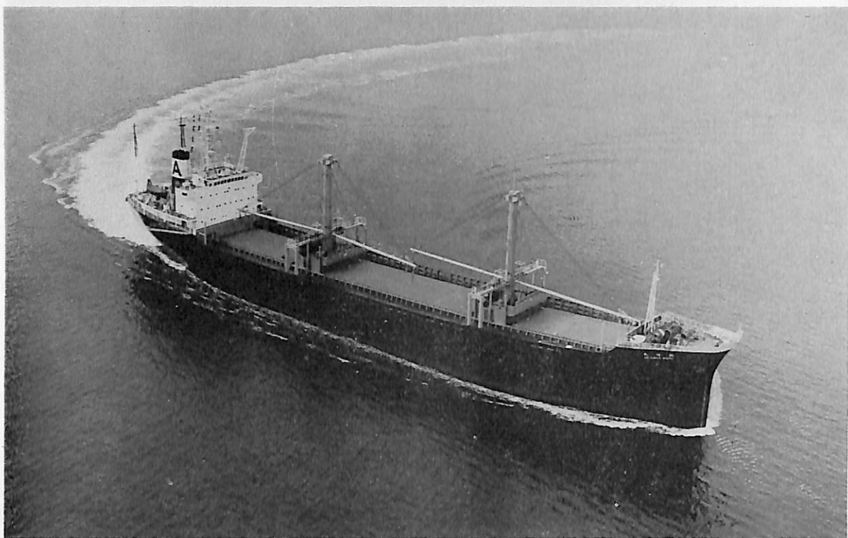
秋 隆 丸 (貨物船) 船主 丸紅株式会社・秋田船舶株式会社 造船所 株式会社宇品造船所 総噸数 6,938.04噸 純噸数 4,375.43噸 遠洋 船級 NK 載貨重量 12,003噸 全長 128.77m 長(垂) 120.00m 幅(型) 19.60m 深(型) 10.50m 吃水 8.252m 満載排水量 15,250噸 主機 伊藤鉄工M558HUS型ディーゼル 機関1基 出力 5,700PS×218RPM 燃料消費量 21.45t/d 航続距離 16,000海里 速力 13.2ノット 汽罐 コク ランコンポジット型 800kg/h 1台 発電機 AC 445V×300KVA×2台 貨物倉(ベール) 13,746.5m 3 (グレー ン) 14,072.3m 3 清水倉 910.4m 3 燃料油倉 1,380.9m 3 乗員 28名 工期 48-9-14, 48-12-23, 49-1-31
