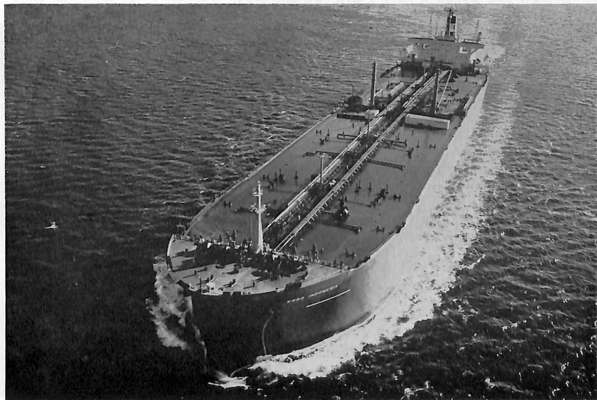
ESSO INDONESIA (油槽船) 船主 Esso Tankers, Inc. (リベリア) 造船所 日本鋼管・津造船所 総噸数 114,796.75噸 純噸数 96,699噸 遠洋 船級 AB 載貨重量 257,105Lt 全長 338.1m 長(垂) 320.0m 幅(型) 51.8m 深(型) 26.7m 吃水 20.904m 満載排水量 294,587Lt 低船首楼付平甲板船 主機 三菱クロス コンパウンド2段減速スチームタービン 出力 31,000PS×85RPM 燃料消費量 150.2t/d 航続距離 22,900海 里 速力 14.9ノット 汽罐 65t/h×61.5kg/cm 2 G×2 発電機 1,650KW×450V×2, 340KW×450V×1 貨油倉 313,020m 3 清水倉 747.4m 3 燃料油倉 10,504.6m 3 乗員 41名 工期 48-6-19, 48-10-15, 49-1-26
