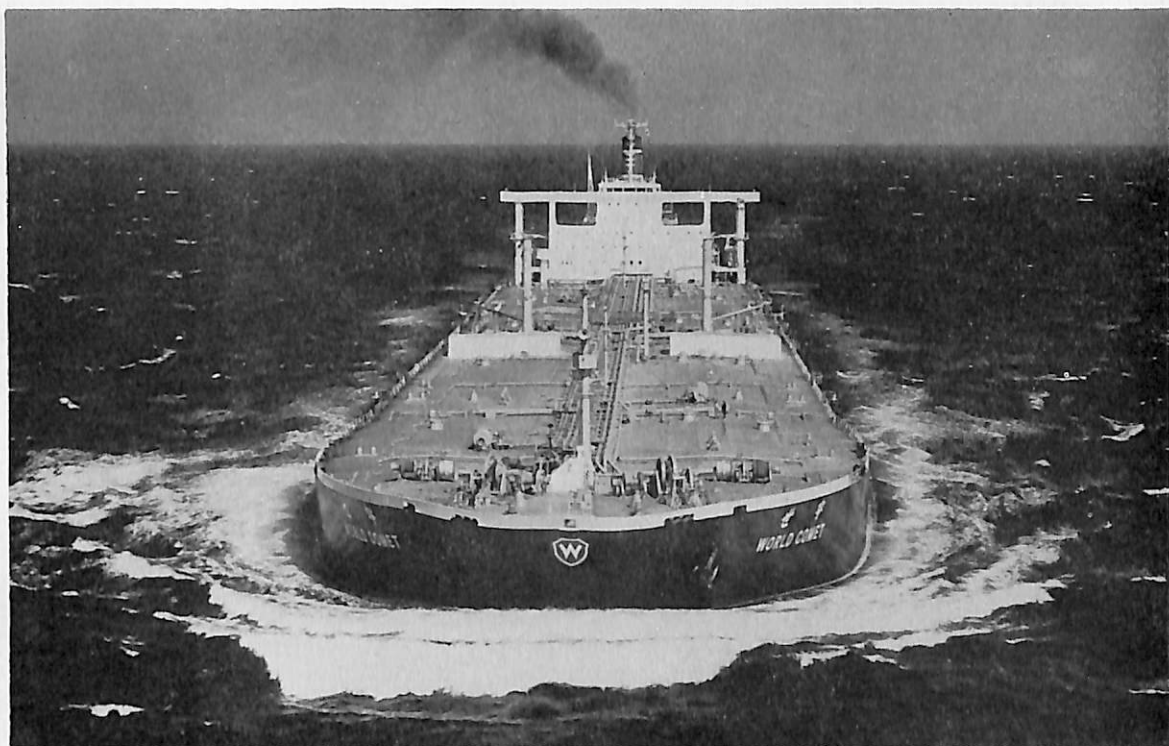
WORLD COMET (世寧) (油槽船) 船主 River Cape Shipping S. A. (パナマ) 造船所 川崎重工・坂出工場 総噸数 105,053噸 遠洋 船級 NK 載貨重量 229,480Lt 全長 319.00m 長(垂) 305.00m 幅(型) 53.00m 深(型) 25.30m 吃水 19.62m 平甲板船 主機 川崎U Aタービン1基 出力 35,000PS×89RPM 燃料消費量 173.0t/d 航続距離 16,000海里 速力 16.3ノット 汽罐 川崎-UMG型ボイラー×2 発電機 1×1,800KVA 450V 貨油槽 288,000m 3 燃料油倉 8,050m 3 清水倉 200m 3 乗員 36名 工期 48-7-17, 48-11-16, 48- 3-5
