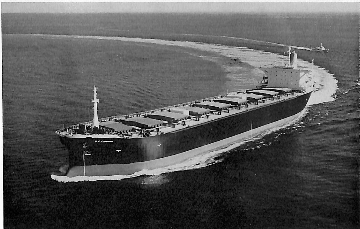
D.C. COLEMAN (ばら積貨物船) 船主 Canadian Pacific(Bermuda)Ltd. 造船所 日本鋼管・鶴見造船所 総噸数 69,903.89噸 純噸数 44,473.05噸 遠洋 船級 LR 載貨重量 125,103噸 全長 260.00m 長(垂) 248.00 m 幅(型) 41.60m 深(型) 23.70m 吃水 16.808m 満載排水量 144,922噸 平甲板 主機 三井B&W 9 K84E F型ディーゼル機関1基 出力 20,800PS×110RPM 燃料消費量 76.4t/d 航続距離 23,200海里 速力15.15ノ ット 汽罐 AAL BORG AQ3×1 10kg/cm 2 ×saturated 発電機 630KW×450V×2, 640KW×AC450V×1 貨物倉 (グリーン) 143,647.2m 3 清水倉 314m 3 燃料油倉 5,256m 3 乗員 42名 工期 48-6-25, 48-10-8, 49- 1-17
