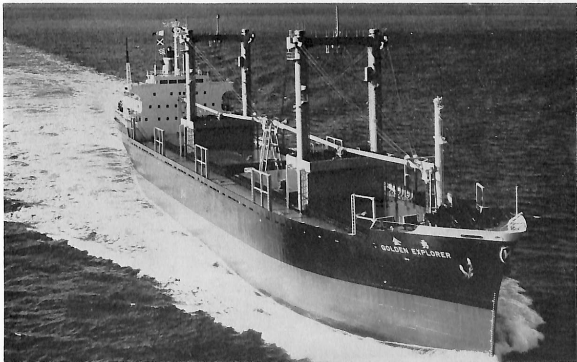
GOLDEN EXPLORER (ばら積貨物船) 船主 Liberian Opal Transports, Inc.(リベリア) 造船所 日立造船・ 向島工場 総噸数 11,169.97噸 純噸数 7,081噸 遠洋 船級 AB 載貨重量 19,361噸 全長 156.155m 長(垂) 146.065m 幅(型) 22.60m 深(型) 12.90m 吃水 7.50m 満載排水量 24,498噸 一層甲板船 主機 日立B&W 6 K62E F型ディーゼル機関1基 出力 7,600PS×140RPM 燃料消費量 30t/d 航続距離 19,100海里 速力 14.7ノット 汽罐 日立フレミングNo.3型 1,350kg/h×1 発電機 380KW, AC450V60Hz×3 貨物倉(ベール) 24,188m 3 (グリーン) 24,668m 3 清水倉 243.23m 3 燃料油倉 1,818.58m 3 乗員 50名 工期 48-8-22, 48- 11-30, 49-1-29 同型船 GOLDEN PIONEER
