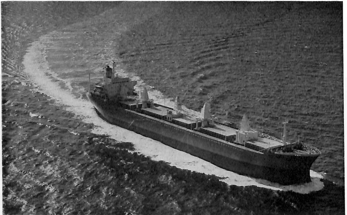
KAPETAN STAMATIS (ばら積貨物船) 船主 Eagle Steam Ship Co. S. A. (ギリシャ) 造船所 株式会社名村造船所 総噸数 15,976.11噸 純噸数 10,952噸 遠洋 船級 AB 載貨重量 26,935噸 全長 177.03m 長(垂) 167.00m 幅(型) 22.90m 深(型) 14.50m 吃水 10.404m 満載排水量 33,493噸 凹甲板型 主機 住友スルザー 7 RND68型ディーゼル機関1基 出力 9,820PS×142RPM 燃料消費量 C 37.6, A 2.0t/d 航続距離 16,500海里 速力 15ノット 汽罐 コ克蘭ボイラー 7 kg/cm 2 ×169.6°C, 1,200kg/h 発電機 AC60Hz, 475KVA 貨物倉(ベール) 32,890m 3 (グレーン) 34,247m 3 清水倉 201.4m 3 燃料油倉 1,988.3m 3 乗員 39名 工期 48-7-23, 48-10-30, 49-1-31
