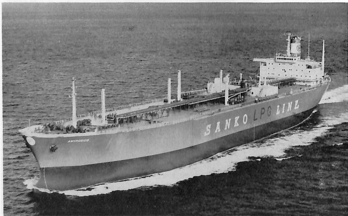
AMVROSIOS (LPG運搬船) 船主 Ivory Steamship Corporation (リベリア) 造船所 三菱重工業・横浜造 船所 総噸数 36,911.28噸 純噸数 24,954.53噸 遠洋 船級 NK 載貨重量 49,806噸 全長 223.96m 長(垂) 213.00m 幅(型) 34.60m 深(型) 21.40m 吃水 11.928m 平甲板船 主機 三菱スルザー6RND90型ディーゼ ル機関1基 出力 14,790\text{PS} \times 116\text{RPM} 燃料消費量 54.3t/d 速力 15.65ノット 汽罐 強風通風, 油質×1, 排 気ガスエコノマイザー×1 発電機 450\text{V} \times 60\text{Hz} \times 700\text{KW} \times 3 貨油倉 70,131.8m 3 清水倉 574m 3 燃料油倉 3,255m 3 乗員 35名 工期 47-12-22, 48-8-17, 49-2-28
