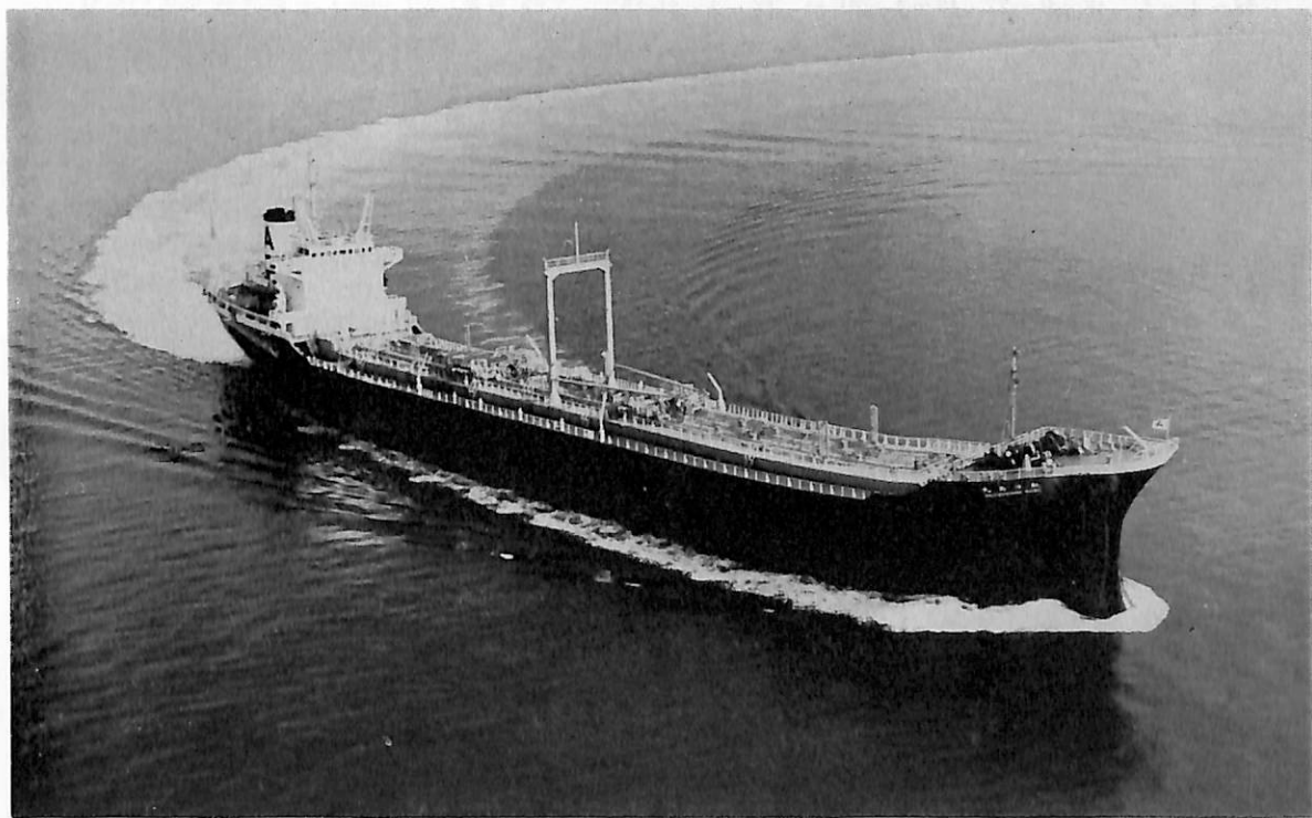
秋津島丸 (油槽船) 船主 丸紅株式会社・秋田船舶株式会社 造船所 株式会社宇品造船所 総噸数 7,983.14噸 純噸数 4,927.61噸 遠洋 船級 NK 載貨重量 13,095噸 全長 129.70m 長(垂) 120.00m 幅(型) 19.80m 深(型) 11.40m 吃水 9.371m 満載排水量 16,961噸 凹甲板型 主機 赤阪鉄工8UEC52/105 D型ディーゼル機関1基 出力 7,200PS×169RPM 燃料消費量 31.5t/d 航続距離 13,700海里 速力 14.0ノット 汽罐 乾燃室式 13,000kg/h×9kg/cm 2 発電機 AC445V×450KVA×2台 貨油倉 16,363.18m 3 清水倉 956.0m 3 燃料油倉 1,514.9m 3 乗員 29名 工期 48-6-19, 48-10-12, 48-11-14
