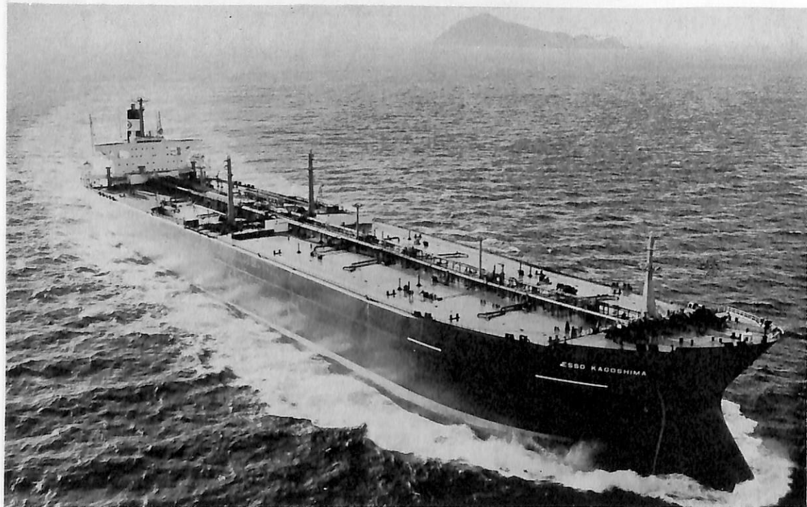
ESSO KAGOSHIMA (油槽船) 船主 Esso Tankers, Inc. (リベリア) 造船所 日本鋼管・津造船所 総噸数 114,796.75噸 純噸数 96,699噸 遠洋 船級 AB 載貨重量 257,034Lt 全長 338.1m 長(垂) 320.0m 幅(型) 51.8m 深(型) 26.7m 吃水 20.904m 満載排水量 294,587Lt 低船首楼付平甲板船 主機 三菱クロス コンパランド2段減速スチームタービン×1基出力 31,000PS×85RPM 燃料消費量 149.2t/d 航続距離 23,200 海里 速力 15.0ノット 汽罐 65t/h×61.5kg/cm 2 G×2 発電機 1,650KW×450V×2, 340KW×450V×1 貨油倉 313,020.0m 3 清水倉 747.4m 3 燃料油倉 10,504.6m 3 乗員 41名 工期 48-4-21, 48-8-8, 48-11-22
