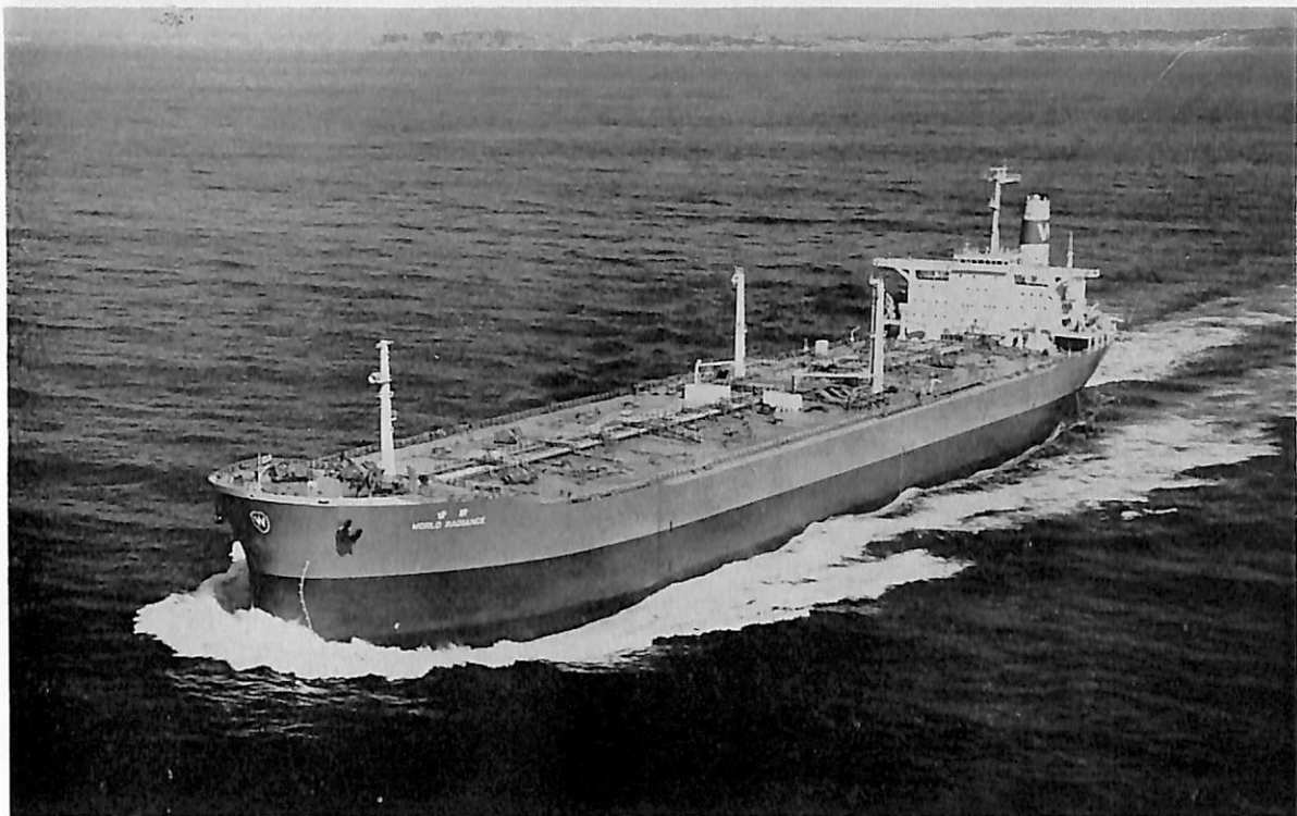
WORLD RADIANCE (油槽船) 船主 Liberian Paplar Transport Inc. (ノルウエー) 造船所 住友重機械工業・浦賀造船所 総噸数 64,820噸 船級 AB 載貨重量 138,899噸 長(垂) 258.00m 幅(型) 44.06m 深(型) 23.07m 吃水 17.00m 主機 住友スルザー9RND90型ディーゼル機関1基 出力 26.100PS×122RPM 速力 15.3ノット 工期 48-7-27, 48-11-19, 49-2-28
