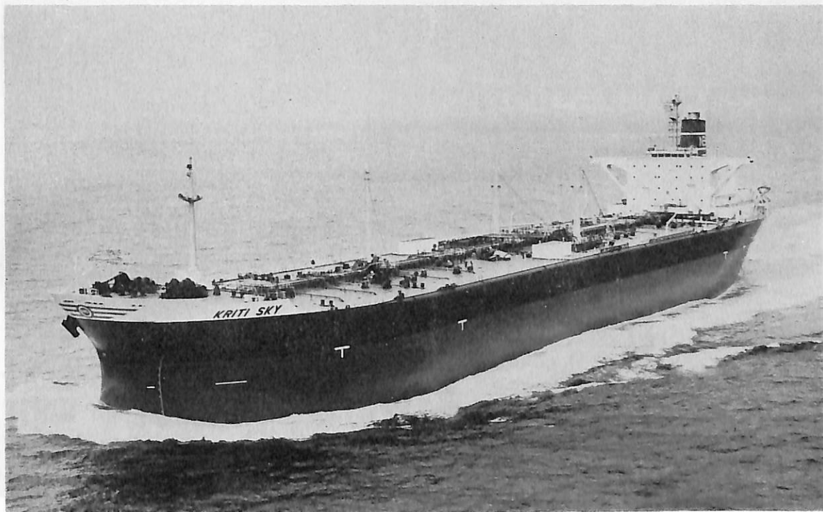
KRITI SKY (油槽船) 船主 Kamellia Compania Naviera S.A (ギリシヤ) 造船所 三菱重工業・横浜造船所 総噸数 46,274噸 純噸数 46,274噸 遠洋 船級 LR 載貨重量 123,382噸 全長 260.63m 長(垂) 247.00m 幅(型) 40.60m 深(型) 22.30m 吃水 16.813m 満載排水量 143,565噸 船首楼付平甲板船 主機 三菱スルザー 9 RND90型ディーゼル機関1基 出力 23,490PS×118RPM 燃料消費量 85t/d 航続距離 24,000海里 速力 15.8ノット 汽罐 三菱-CE Water tube ボイラ×1 発電機 AC450V×770KW×3 貨油倉 147,541m 3 清水倉 304m 3 燃料油倉 6,323m 3 乗員 44名 工期 48-5-31, 48-10-25, 49-1-18
