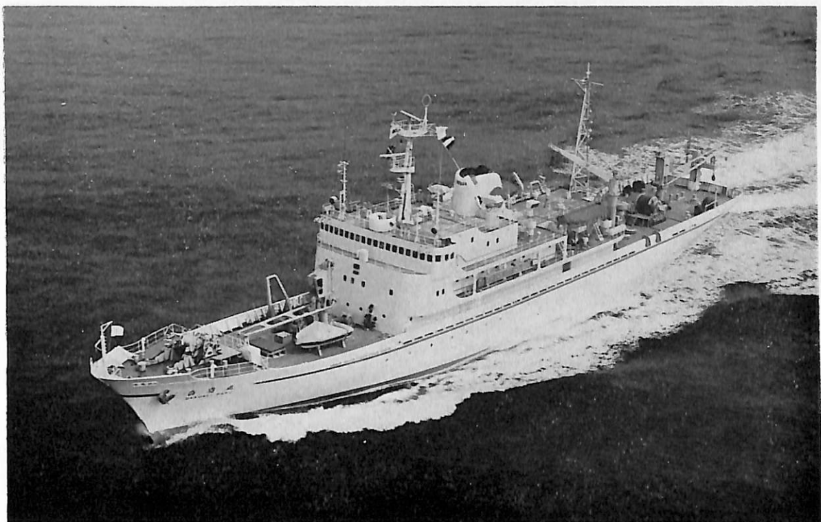
白 嶺 丸 (地質調査船) 船主 金属鉱業事業団 造船所 三菱重工業・下関造船所 総噸数 1,821.60噸 純噸数 548.94噸 遠洋 船級 NK 載貨重量 951.0噸 全長 86.95m 長(垂) 77.00m 幅(型) 13.40m 深(型) 5.30m 吃水 5.01m 満載排水量 2,871噸 全通楼甲板型 主機 三菱6 UET 45/75 C型ディーゼル機関1基 出力 3,230PS×218RPM 燃料消費量 12.0t/d 航続距離 15,000海里 速力 15.00ノット 汽罐 クレイトンWHO-75, 935kg/h×1 発電機 AC450V, 60%, 750KVA×3 清水倉 258m 3 燃料油倉 620m 3 乗員 35名, 研究員 20名 工期 48-4-19, 48-10-11, 49-3-31 設備 人工衛星航法システム, 観測用機器, 研究室, パウスラスター, 可変ピッチプロペラ
