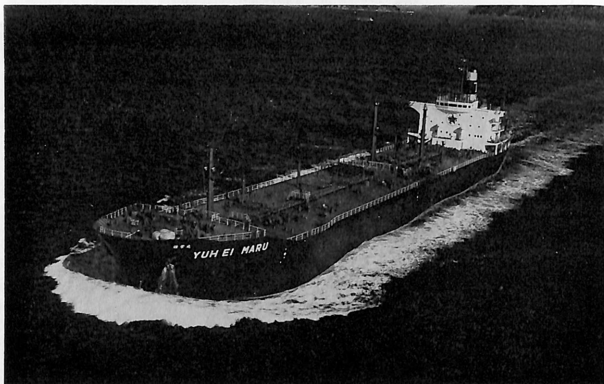
雄 栄 丸 (油槽船) 船主 東京近海油送株式会社 造船所 常石造船株式会社 総噸数 20,792.13噸 純噸数 12,915.44噸 近海 船級 NK 載貨重量 36,505噸 全長 189.00m 長(垂) 180.00m 幅(型) 27.000m 深(型) 14.950m 吃水 11.024m 満載排水量 45,141噸 船首楼付平甲板型 主機 三井 B & W 6 K84EF型ディーゼル機関1基 出力 13,200PS×108RPM 燃料消費量 49.5t/d 航続距離 11,700海里 速力 15.5ノット 汽罐 IHI ADM321 発電機 610KW×2 貨油倉 44,774.5m 3 清水倉 297.1m 3 燃料油倉 FO 1,746.0m 3 DO 271.9m 3 乗員 30名 工期 48-7-23, 48-10-16, 49-1-17
