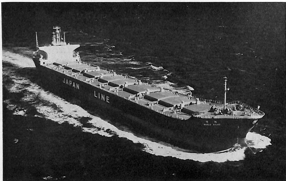
WORLD ATLAS (ばら積貨物船) 船主 Liberian Cutlass Transports Inc. (リベリア) 造船所 三菱重工業 神戸造船所 総噸数 32,044.55噸 純噸数 22,759.95噸 遠洋 船級 BV 載貨重量 61,494噸 全長 238.00m 長(垂) 225.00m 幅(型) 32.20m 深(型) 18.20m 吃水 12.20m 満載排水量 75,326噸 船首楼付平甲板船 主 機 三菱スルザー 6 RND90型ディーゼル機関1基 出力 15,660PS×118RPM 燃料消費量 58.0t/d 速力 15.7 ノット 汽罐 コクラン 1,850kg/h×1 発電機 AC450V, 540KW×2 貨物倉(グレーン) 75,887.4m 3 清水倉 567.4m 3 燃料油倉 4,239.8m 3 乗員 35名 工期 48-6-19, 48-10-25, 49-2-14 機関部はBV(AUT) 適用
