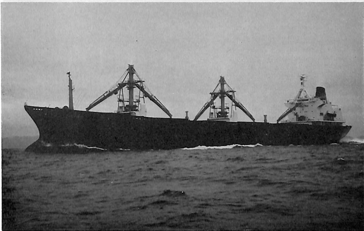
PACGLORY (貨物船) 船主 Great Pacific Shipping Co. (リベリア) 造船所 石川島播磨重工業・東京工場 総噸数 13,200.58噸 純噸数 9,471噸 遠洋 船級 AB 載貨重量 22,592噸 全長 164.33m 長(垂) 155.448m 幅(型) 22.86m 深(型) 13.56m 吃水 9.848m 船尾樓付平甲板 主機 IHI-SEMT-ビールスチック16PC- 2V型ディーゼル機関1基 出力 7,200PS×482RPM 燃料消費量 33.7t/d 航続距離 15,000海里 速力 15.0 ノット 汽罐 煙管式コンポジットボイラ2基 貨物倉(ペール) 29,843.2m 3 (グレーン) 30,801.0m 3 清水倉 201.4m 3 燃料油倉 1,389.6m 3 乗員 30名 工期 48-10-5, 48-12-11, 49-2-20
