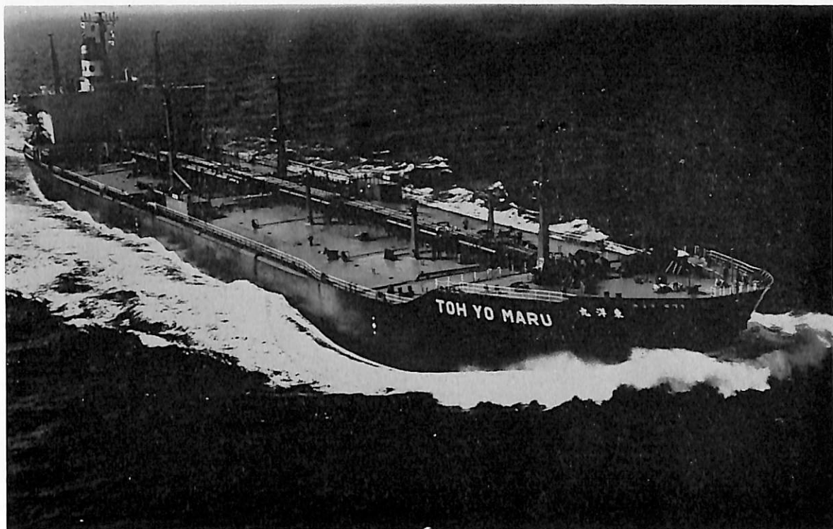
東 洋 丸 (油槽船) 船主 東海運株式会社 造船所 常石造船株式会社 総噸数 44,552.33噸 純噸数 29,365.71噸 遠洋 船級 NK 載貨重量 78,988噸 全長 246.00m 長(垂) 235.00 m 幅(型) 37.600m 深(型) 18.000m 吃水 12.830m 満載排水量 94,932噸 船首楼付平甲板型 主機 三井 B & W 9 K 84EF 型ディーゼル機関 1 基 出力 19,700PS×108RPM 燃料消費量 74.6t/d 航続距離 19,300海里 速力 15.9ノット 汽罐 40,000kg/h×16kg/cm 2 発電機 740KW×2 燃料油倉 98,143.3m 3 清水倉 521.5m 3 乗員 30名 工期 48-4-23, 48-8-9, 48-10-31
