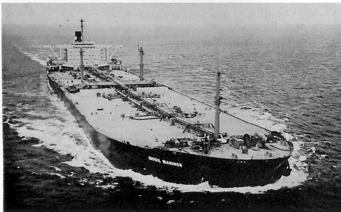
MOBIL MARINER (油槽船) 船主 Mobil Shipping and Transportation Company (リベリア) 造船所 住友重機械工業・追浜造船所 総噸数 121,500噸 船級 AB 載貨重量 270,714噸 長(垂) 324.00m 幅(型) 54.40m 深(型) 26.90m 吃水 20.96m 主機 住友スタルラバルAPタービン 出力 38,000PS×91RPM 速力 15.7ノット 工期 48-7-18, 48-11-21, 49-3-10
