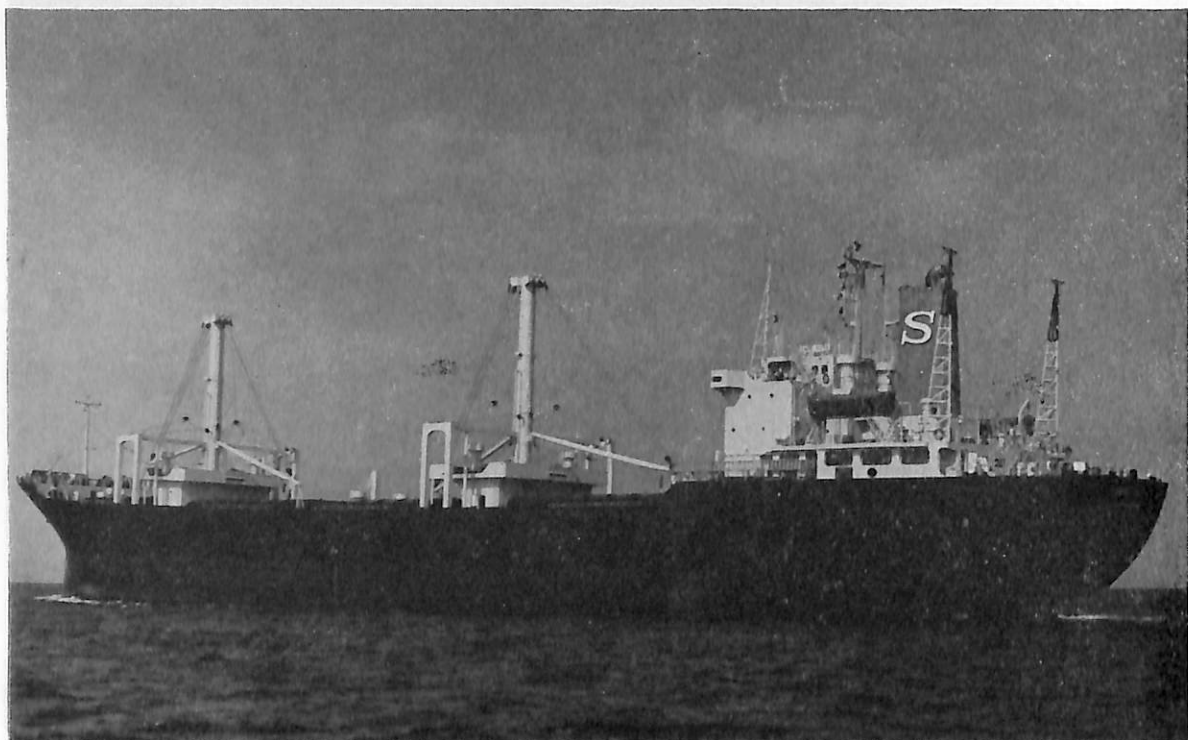
CAPE SOYA (貨物船) 船主 Taurus Transportation Co., Ltd. (パナマ) 造船所 樽崎造船株式会社 総噸数 10,055.05噸 純噸数 5,994.38噸 遠洋 船級 NK 載貨重量 16,165.1噸 全長 139.96m 長(垂) 129.50 m 幅(型) 21.40m 深(型) 12.55m 吃水 9.535m 満載排水量 20,856.9噸 凹型二層甲板船 主機 赤坂鉄工業 UEC 52/105 D 型ディーゼル機関 1 基 出力 6,800 PS×166 RPM 燃料消費量 26.9t/d 航続距離 15,213海里 速力 13.75ノット 汽罐 7 kg/cm 2 G ボイラー×1 発電機 360 KVA×AC 445V×60Hz×2 貨物倉(ベール) 19,024.4m 3 (グリーン) 20,782.4m 3 清水倉 412.4m 3 燃料油倉 1,520.2m 3 乗員 40名 工期 48-9-4, 48 -12-13, 49-3-9
