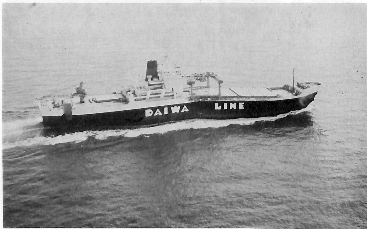
ほなべ丸 (コンテナ兼自動車運搬) 船主 大和海運株式会社・東京船舶株式会社 造船所 林兼造船・下関造船所 総噸数 7,716.26噸 純噸数 3,682.12噸 遠洋 船級 NK 載貨重量 8,712噸 全長 146.00m 長(垂) 135.00m 幅(型) 22.40m 深(型) 13.80m 吃水 7.85m 満載排水量 14,159噸 凹甲板船 主機 三菱M AN V 6 V 52/55型ディーゼル機関 1基 出力 10,800PS×416.3RPM 燃料消費量 41.4t/d 航続距離 13,000海里 速力 17.5ノット 汽罐 RHO-125クレイトン式蒸気発生機 1台 排ガスエコマイザー 1台 貨物倉(グリーン) 10,238m 3 清水倉 549m 3 燃料油倉 1,900m 3 乗員 32名 工期 48-7-28, 48-11-10, 49-2-23 設備 30Lt コンテナクレーン 1台, 15t デッキクレーン 1台, ランプウェイ×1台 コンテナ艙を除き3層の甲板を有し、乗用車を搭載
