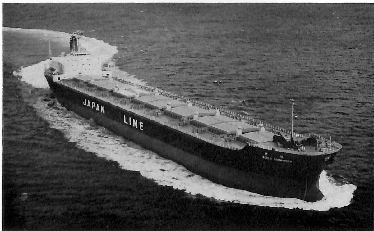
WORLD COMMANDER (ばら積貨物船) 船主 Liberian Chamois Transports Inc. (リベリア) 造船所 三 菱重工業・神戸造船所 総噸数 32,044.55噸 純噸数 22,759.95噸 遠洋 船級 BV 載貨重量 61,438Lt 全長 238.00m 長(垂) 225.00m 幅(型) 32.20m 深(型) 18.20m 吃水 12.20m 満載排水量 75,326Lt 船首楼付 平甲板船 主機 三菱スルザー 6 RND90型ディーゼル機関×1 出力 15,660PS×118RPM 燃料消費量 58.0t/d 航続距離 24,000海里 速力 15.7ノット 汽罐 コクラン 1,850kg/h×1 発電機 AC450V, 540KW×2 貨物倉 (グレーン) 75,887.4m 3 清水倉 567.4m 3 燃料油倉 4,239.8m 3 乗員 35名 工期 48-8-24, 48-12-25, 49- 3-28 同型船 WORLD ATLAS
