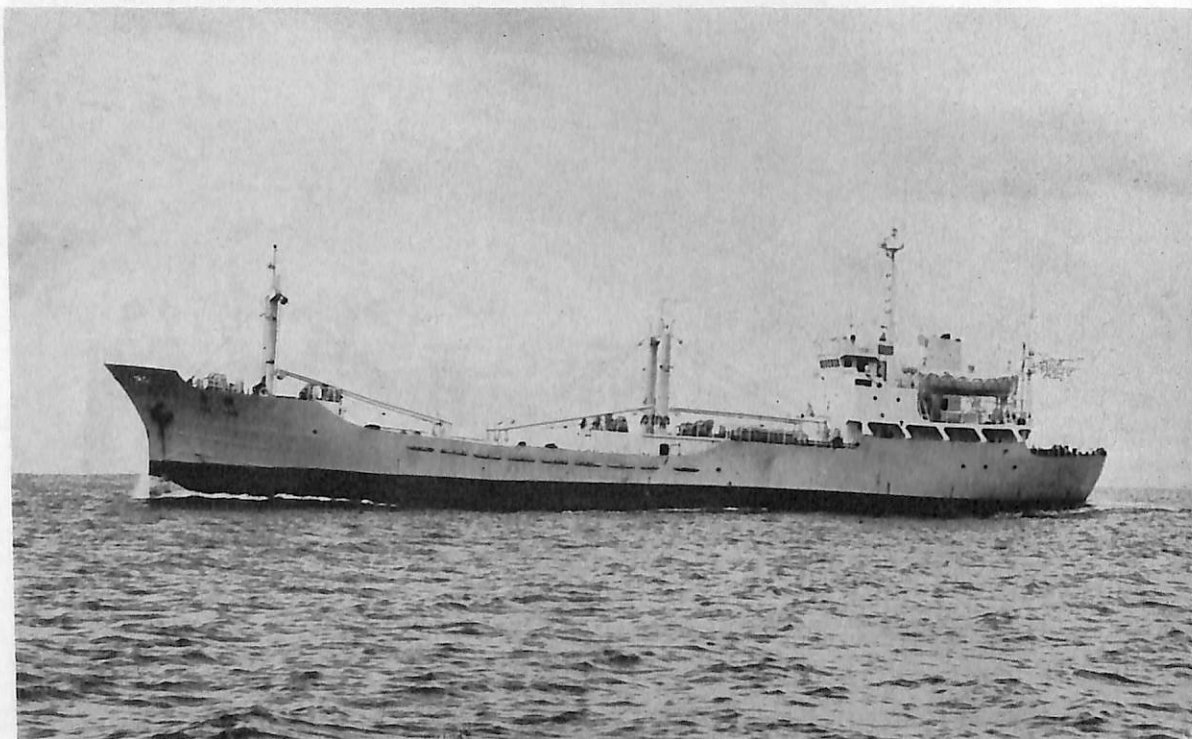
ZHE LENG No. 3 (浙冷3号) (冷蔵運搬船) 船主 中国機械進出口總公司 (中華人民共和国) 造船所 西井船渠株式会社 総噸数 997.95噸 純噸数 531.68噸 遠洋 船級 NK 載貨重量 1,468.62噸 全長 71.40m 長(垂) 64.00m 幅(型) 11.00m 深(型) 5.50m 吃水 4.80m 満載排水量 2,385.00噸 凹甲板長船尾樓型 主機 阪神内燃機6 LUS-38型ディーゼル機関1基 出力 1,955PS×294RPM 燃料消費量 9.54t/d 航続距離 11,850海里 速力 13.00ノット 汽罐 398kg/h 発電機 320KVA×2 45KVA×1 貨物倉(ペール) 1,645.32m 2 清水倉 91.75m 3 燃料油倉 347.05m 3 乗員 34名 工期 48-9-28, 48-12-21, 49-3-28
