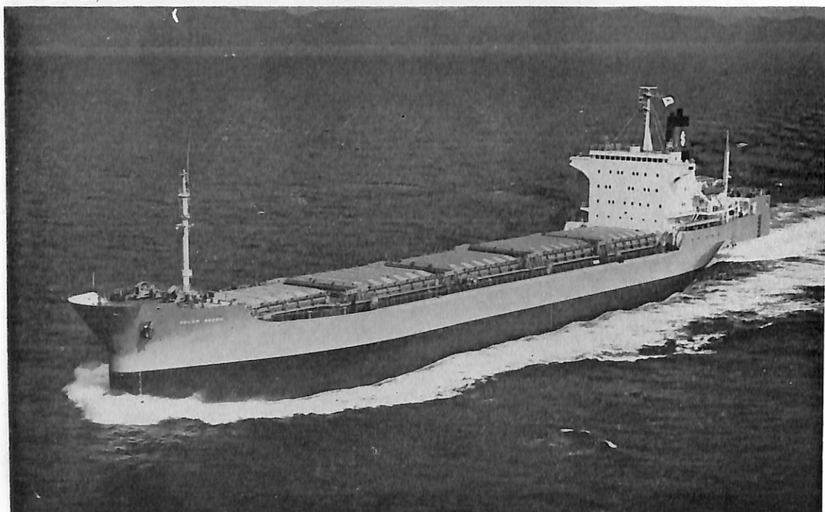
COLON BROWN (ばら積運搬船) 船主 Oceanways Navigation Company (リベリア) 造船所 佐世保重工業 佐世保造船所 総噸数 15,470.97噸 純噸数 9,304.68噸 遠洋 船級 LR 載貨重量 26,137Lt 全長 177.970m 長(垂) 164.00m 幅(型) 25.90m 深(型) 14.10m 吃水 9.45m 満載排水量 33,871Lt 凹甲板型 主機 IHI スルザー 7 RND68型ディーゼル機関1基 出力 10,395BPS×144.8RPM 燃料消費量 165gr/bps/hr 航続距離 9,900海里 速力 15.36ノット 汽罐 1,500kg/h 発電機 1,040KVA 450VAC×3 貨物倉(グレーン) 21,406m 3 清水倉 270.0m 3 燃料油倉 180.2m 3 乗員 51名 工期 48-8, 48-12, 49-4
