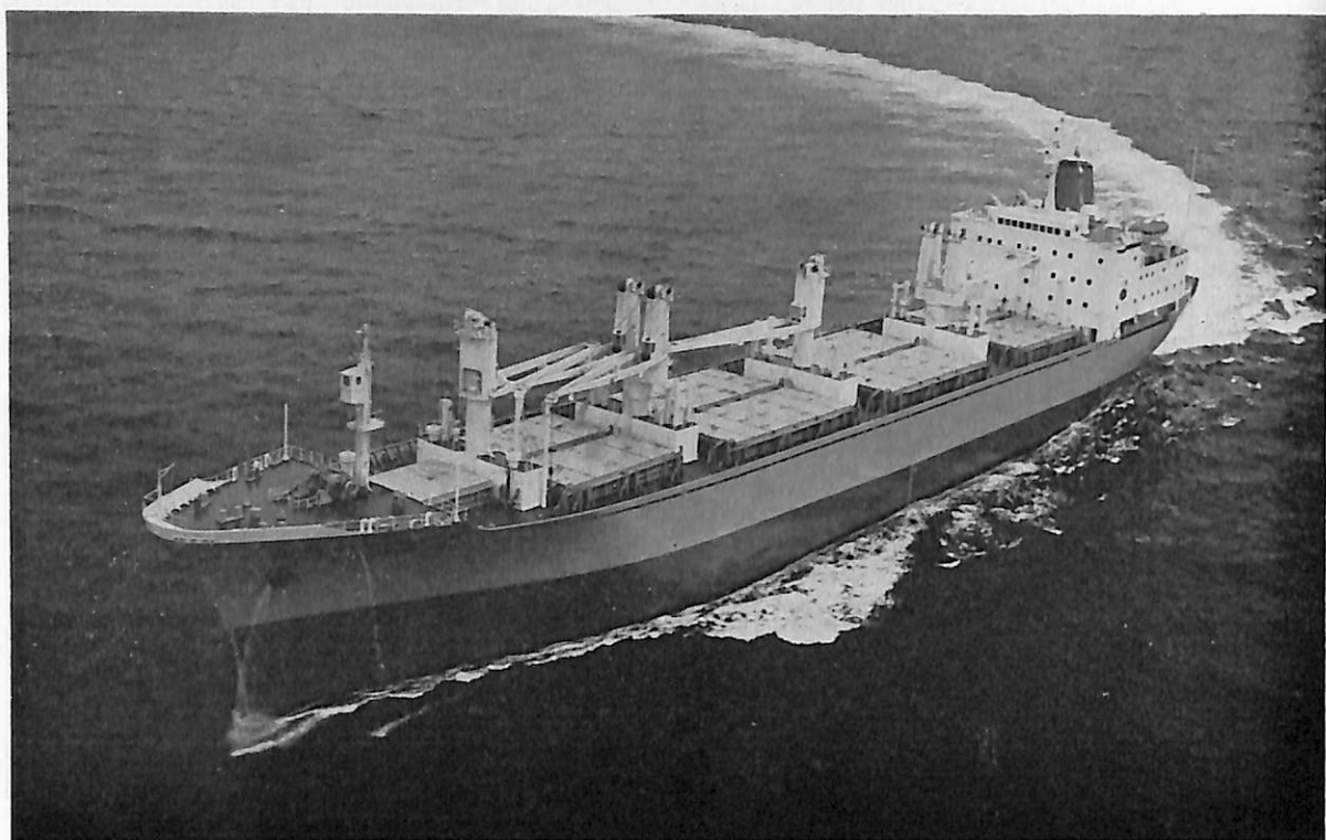
OCEAN ANDURANCE (貨物船) 船主 Enterprise & Shipping Company (パナマ) 造船所 三菱重工業・下関造船所 総噸数 8,026噸 純噸数 8,026噸 遠洋 船級 AB 載貨重量 19,922噸 全長 163.72m 長(垂) 152.00m 幅(型) 22.86m 深(型) 14.40m 吃水 10.738m 満載排水量 27,004Lt 船首楼付平甲板船 主機 三菱スルザー6 RND76型ディーゼル機関1基 出力 10,800PS×118RPM 燃料消費量 39.2t/d 航続距離 14,500海里 速力 17.6ノット 汽罐 コクラン型 200kg/h 発電機 500KW×3 貨物倉(ベール) 26,659m 3 (グリーン) 28,380m 3 清水倉 350m 3 燃料油倉 1,821m 3 乗員 48名,外2名 工期 48-9-11, 48-11-26, 49-4-10
