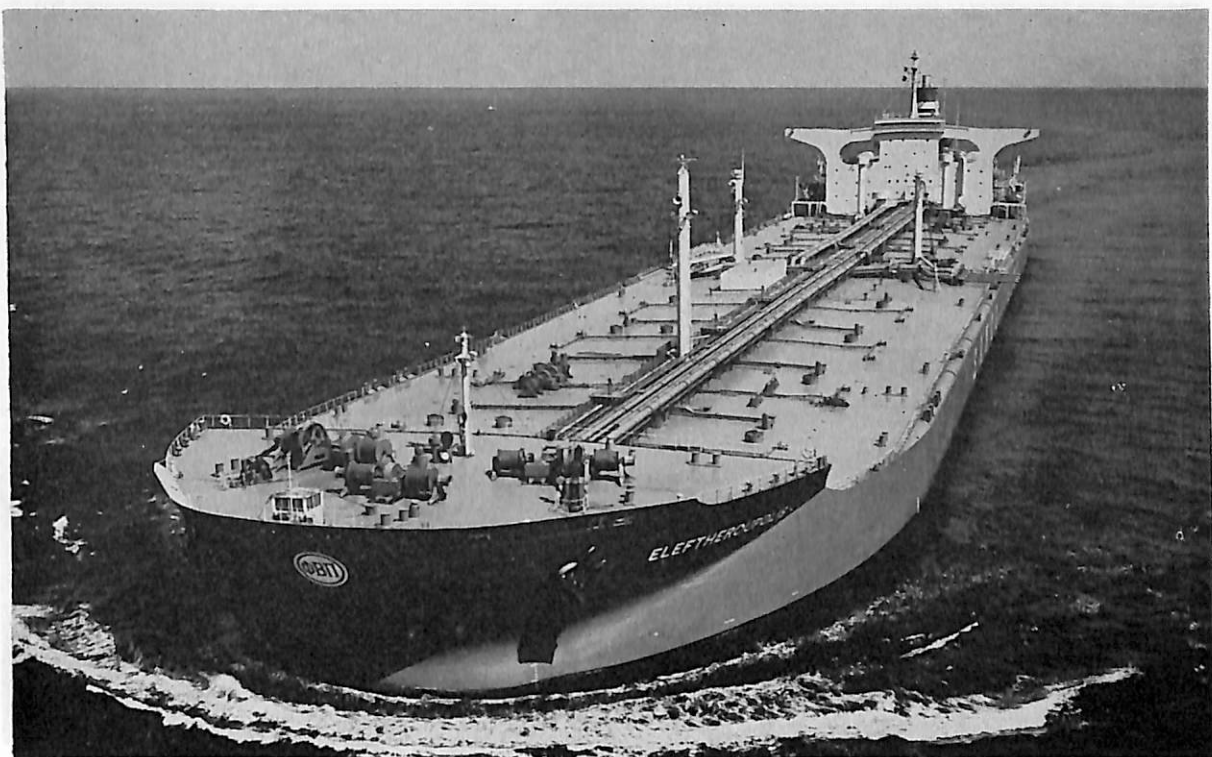
ELEFTHEROUPOLIS (タンカー) 船主 Elefthheroupolis Shipping Inc. (リベリア) 造船所 佐世保重工業・佐世保造船所 総噸数 132,034.13噸 純噸数 109,577.70噸 遠洋 船級 LR 載貨重量 285,506噸 全長 339.75m 長(垂) 324.00m 幅(型) 53.50m 深(型) 28.00m 吃水 21.795m 満載排水量 324,801噸 船首楼付平甲板型 主機 IHIクロスコンパウンド型タービン 出力 36,000PS×90RPM 燃料消費量 219.0g/shp/h 航続距離 27,000海里 速力 15.62ノット 汽罐 SASEBO-FW "MD-80" TYPE 発電機 AC 450V×3,015A×1,880KW×1 AC 450V×1,604A×1,000KW×2 貨油倉 335,000m 3 清水倉 240m 3 燃料油倉 14,000m 3 乗員 42名 工期 48-8, 48-12, 49-4
