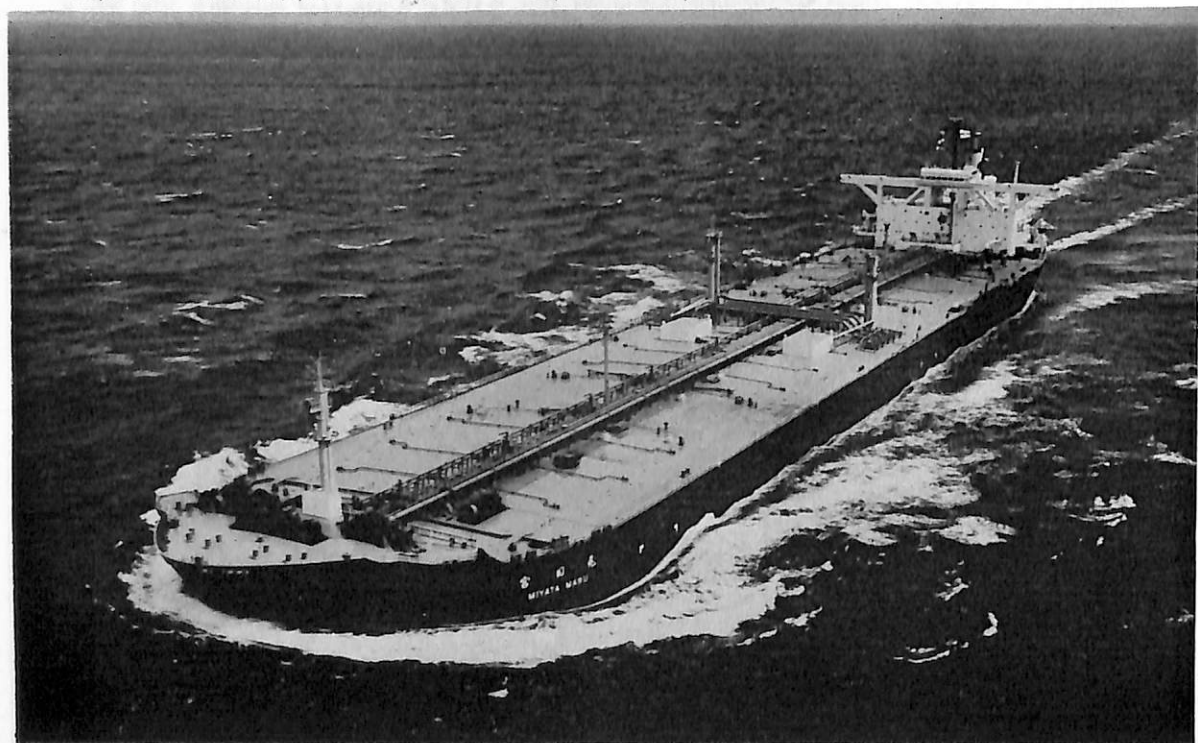
宮田丸 (油槽船) 船主 出光タンカー株式会社 造船所 三菱重工業・長崎造船所 総噸数 130,670.17噸 純噸数 93,855.17噸 遠洋 船級 NK 載貨重量 254,163噸 全長 336.85m 長(垂) 320.00m 幅(型) 53.60m 深(型) 26.40m 吃水 19.738m 船首樓付平甲板船 主機 三菱MS-36-2型船用ター ビン×1 出力36,000PS×90RPM 燃料消費量 177.1t/d 航続距離 16,200海里 速力 15.65ノット 汽罐 三菱CE-V2M-8 W型ボイラ×2 発電機 AC450V×1,250KW×1,800rpm×1 貨油倉 303,532m 3 清水倉 477m 3 燃料油倉 8,753m 3 乗員 36名, 外7名 工期 48-8-21, 49-1-16, 49-4-12 同型船 沖ノ島丸ノ 高宮丸
