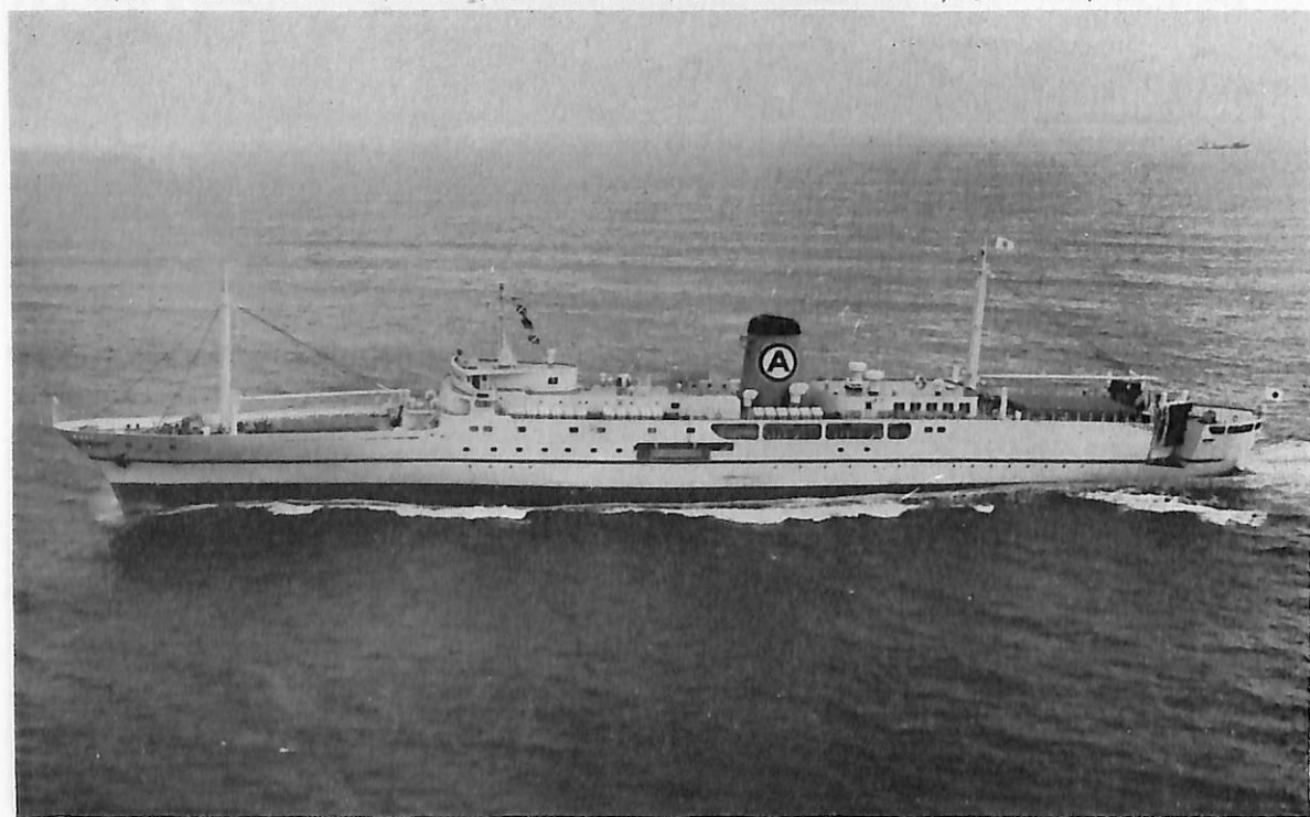
神戸丸 (旅客船) 船主 大島運輸株式会社 造船所 三菱重工業・下関造船所 総噸数 4,987.38噸 純噸数 2,712噸 近海 船級 JG 載貨重量 2,848噸 全長 143.43m 長(垂) 127.00m 幅(型) 16.80m 深(型) 7.20m 吃水 6.52m 満載排水量 7,268噸 主機 三菱8 UEC52/105D型ディーゼル機関2基 出力 2×7,200PS×169RPM 燃料消費量 53.5t/d 航続距離 4,500海里 速力 22.5ノット 汽罐 クレイトン 2,100kg/h 発電機 687.5KVA×3 貨物倉(ベール) 3,111m 3 (グリーン) 3,400m 3 清水倉 311m 3 燃料油倉 620m 3 乗員 55名 工期 48-10-22, 49-1-11, 49-4-19 設備 Cpp, パウラスター
