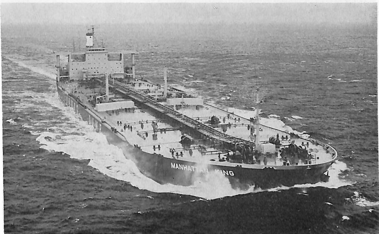
MANHATTAN KING (油槽船) 船主 Crown Tanker Corporation (シンガポール) 造船所 川崎重工業・坂出造船事業部 総噸数 105,188.22噸 純噸数 88,579.38噸 遠洋 船級 NK 載貨重量 233,493噸 全長 319.80m 長(垂) 305.00m 幅(型) 53.00m 深(型) 25.30m 吃水 19.618m 満載排水量 268,008噸 平甲板型 主機 川崎UA-360型船用タービン 出力 35,000PS×89RPM 燃料消費量 174.3t/d 航続距離 16,960海里 速力 16.37ノット 汽罐 川崎UMG 72/56-UA 2胴水管式2基 発電機 1,600KW, 2,000KVA AC 450V×1 720KW, 900KVA AC 450V×2 貨油倉 287,707.10m 3 清水倉 594.49m 3 燃料油倉 8,336.44m 3 乗員 40名 工期 48-8-3, 48-12-25, 49-4-5 設備 ノズルプロペラ装備
