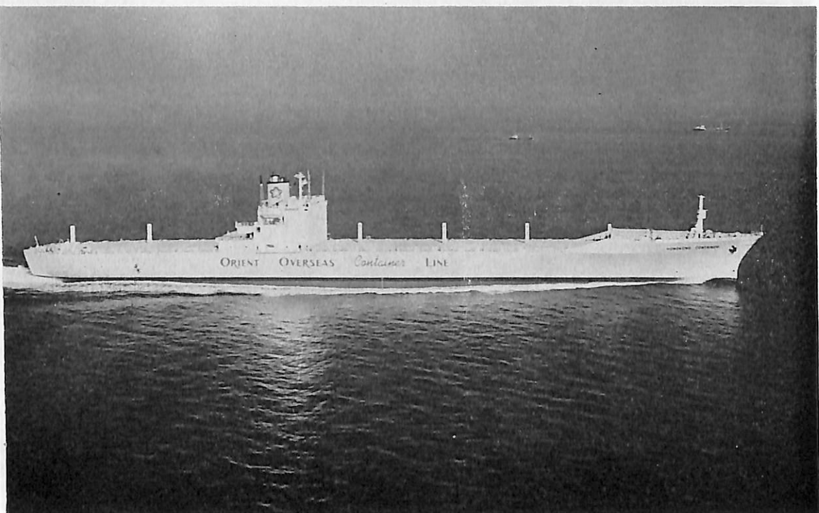
HONGKONG CONTAINER (コンテナ運搬船) 船主 Orient Express Container Services Inc. (リベリア) 造船所 川崎重工業・神戸工場 総噸数 36,884.74噸 純噸数 23,485.49噸 遠洋 船級 NK, AB 載貨重量 35,768噸 全長 264.50m 長(垂) 248.00m 幅(型) 32.20m 深(型) 19.90m 吃水 12.037m 満載排水量 59,206噸 長船首楼付平甲板船 主機 川崎MAN-K10SZ105/180型ディーゼル機関×2 出力 2×34,000PS× 104RPM 燃料消費量 256.5t/d 航続距離 22,200海里 速力 26.56ノット 汽罐 舶用乾燃室式丸ボイラ1基 発電機 1,375KVA×4 コンテナ搭載数 上甲板上 1,012個 倉内 1,056個 計 2,068個 清水倉 641.0m 3 燃料油 倉 9,944.3m 3 乗員 45名 工期 48-3-1, 48-10-12, 49-4-5 特徴 2軸1枚舵
