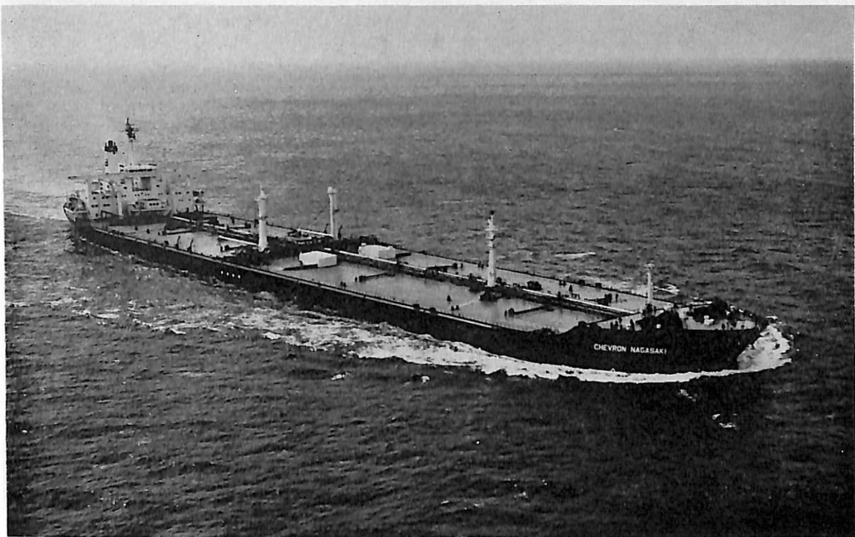
CHEVRON (油槽船) 船主 Chevron Transports Corporation (リベリア) 造船所 三菱重工業・長崎造船所 総噸数 118,147.10噸 純噸数 100,837噸 遠洋 船級 AB 載貨重量 264,006噸 全長 338.629m 長(垂) 320.00 m 幅(型) 53.60m 深(型) 26.40m 吃水 67' -5 3 / 8 " 船首楼付平甲板船 主機 三菱2段減速装置付船用タービ ン 出力 34,000PS×90RPM 燃料消費量 165t/d 航続距離 25,300海里 速力 15.40ノット 汽罐 三菱CE- V 2M-8W型ボイラー×2 発電機 AC450V×1,500kW×1,500rpm×2 清水倉 218.5m 3 貨油倉 320,552.1 m 3 燃料油倉 8,753m 3 乗員 51名, 外8名 工期 48-8-1, 48-10-23, 49-4-2
