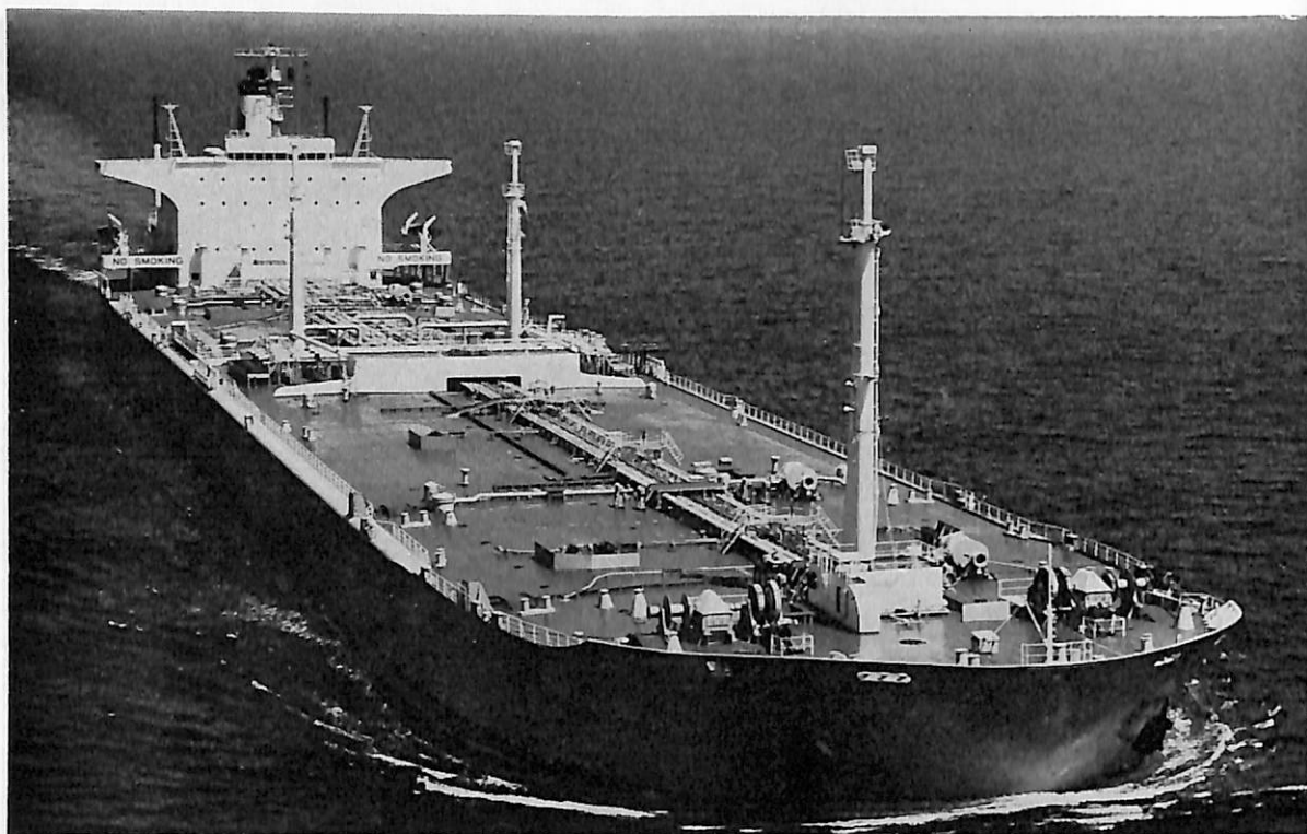
博 陽 丸 (油槽船) 船主 竹林汽船株式会社 造船所 幸陽船渠株式会社 総噸数 59,060.28噸 純噸数 37,193.44噸 遠洋 船級 NK 載貨重量 100,100噸 全長 258.160m 長(垂) 248.412m 幅(型) 38,938m 深(型) 21.031m 吃水 14.679m 満載排水量 122,056噸 平甲板型 主機 三井 B & W 9 K84EF型ディーゼル機関1基 出力 21,100PS×110RPM 燃料消費量 81.99t/d 航続距離 21,390海里 速力 15.2ノット 汽罐 18kg/cm 2 ×60,000kg/h 発電機 700KVA×450V×2 875KVA×450V×1 貨油倉 127,059.6m 3 清水倉 548.8m 3 燃料油倉 5,747.7m 3 乗員 31名 工期 48-8-27, 48-12-27, 49-4-25
