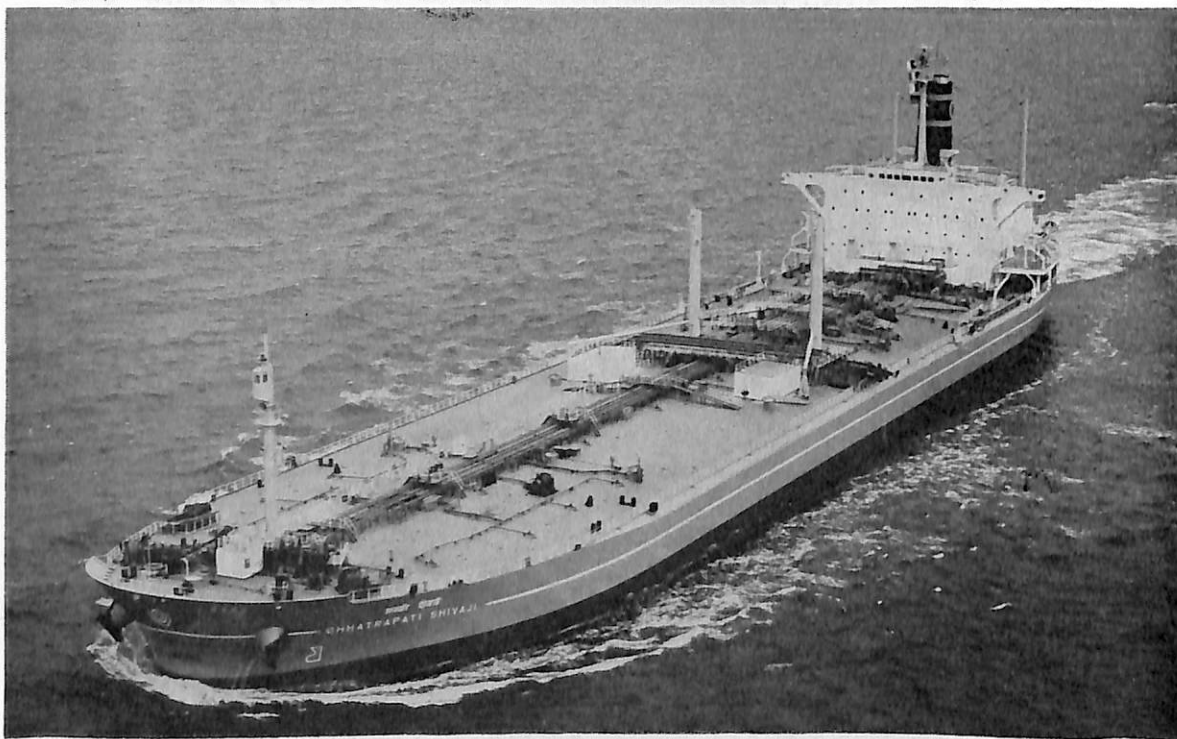
CHHATRAPATI SHIVAJI (油槽船) 船主 The Shipping Corporation of India Ltd (インド) 造船所 三菱重工業・神戸造船所 総噸数 51,528.42噸 純噸数 36,709.14噸 遠洋 船級 AB 載貨重量 88,077Lt 全長 237.164 m 長(垂) 226.00 m 幅(型) 39.40 m 深(型) 18.70 m 吃水 13.948 m 満載排水量 106,245Lt 平甲板型 主機 三菱スルザー 7 RND90型ディーゼル機関1基 出力 17,250PS×116RPM 燃料消費量 62.5t/d 航続距離 24,000海里 速力 15.3ノット 汽罐 三菱ダブルエアポレーション型32t/h×2 発電機 1,000KVA×450V×3 貨油倉 105,816.6m 3 清水倉 312.9m 3 燃料油倉 4,999.1m 3 乗員 69名 工期 48-7-24, 48-12-4, 49-4-12
