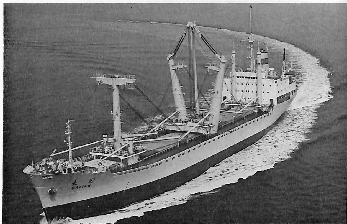
大 田 (TATIAN)(貨物船) 船主 China National Machinery Import & Export Corporation 造船所 日立造船・向島工場 総噸数 10,715.31噸 純噸数 5,782.3噸 遠洋 船級 LR 載貨重量 14,469噸 全長 154.90m 長(垂) 145.00m 幅(型) 22.00m 深(型) 12.00m 吃水 9.082m 満載排水量 20,613噸 四甲 板型 主機 日立B&W 6 K62EF型ディーゼル機関1基 出力 7,600PS×140RPM 燃料消費量 30.7t/d 航続 距離 14,600海里 速力 15.6ノット 汽罐 日立フレミング45型×1 発電機 525KVA, AC400V 50Hz×3 貨物 倉(ベール) 19,392.7m 3 (グリーン) 20,574.9m 3 清水倉 366.2m 3 燃料油倉 1,225.2m 3 乗員 55名 工期 48- 11-5, 49-2-9, 49-5-11
