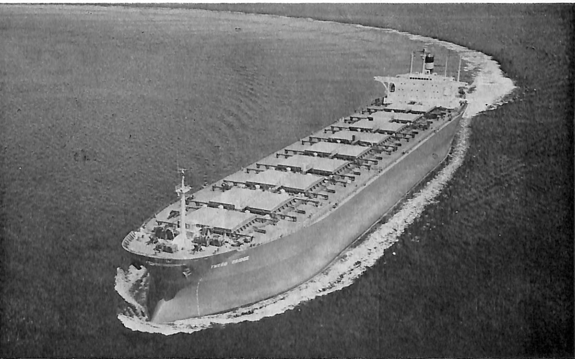
TWEED BRIDGE (ばら積貨物船) 船主 Field Tanic Steam Ship Co.Ltd(英) 造船所 三菱重工業・広島造船所 総噸数 72,331.33噸 純噸数 46,132.76噸 遠洋 船級 LR 載貨重量 129,920噸 全長 261.00m 長(垂) 247.00m 幅(型) 40.60m 深(型) 24.00m 吃水 17.612m 満載排水量 150,845噸 平甲板型 主機 三菱スルザー 8 RND90型ディーゼル機関1基 出力 20,880PS×118RPM 燃料消費量 75.5t/d 航続距離 29,900海里 速力 15.0ノット 汽罐 コクラン型 2,000kg/h×7 kg/cm 2 G 発電機 750KW×937.5KVA×AC450V×3 貨物倉(グリーン) 140,126.2m 3 清水倉 592.5m 3 燃料油倉 7,284.3m 3 乗員 48名 工期 48-9-27, 48-12-21, 49-4-5
