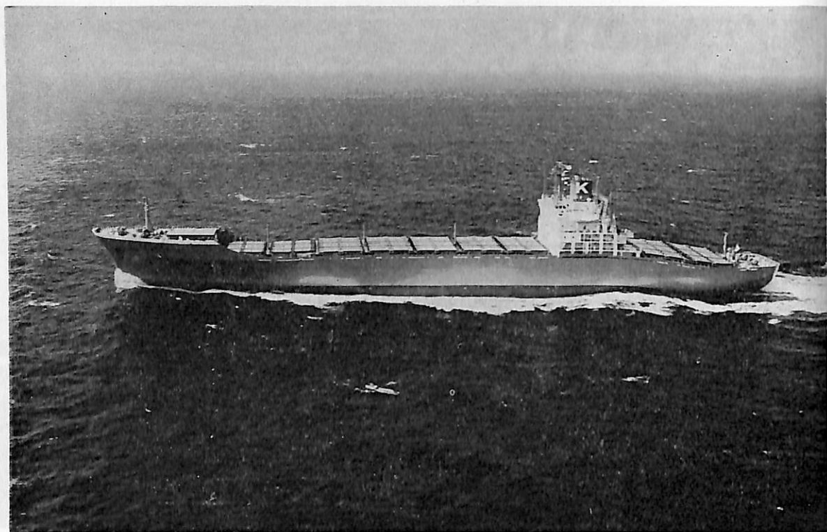
らいおんず げいと ぶりっじ (コンテナ船) 船主 川崎汽船株式会社 造船所 石川島播磨重工業・相生工場 総噸数 29,860.74噸 純噸数 16,782.79噸 遠洋 船級 NK 載貨重量 26,881噸 全長 219.00m 長(垂) 204.00 m 幅(型) 31.20m 深(型) 18.90m 吃水 11.227m 船首楼付平甲板船 主機 IHIスルザー 9 RND105型ディー ザール機関1基 出力 30,600PS×102.3RPM 燃料消費量 111.1t/d 航続距離 18,400海里 速力 22.80ノット 汽罐 横煙管式×1 発電機 AC1000KW×60Hz×450V×3 コンテナ積載 (20)1,441 清水倉 677.4m 3 燃料油倉 4,946.3m 3 乗員 28名外5名 工期 48-7-11, 48-11-16, 49-4-4
