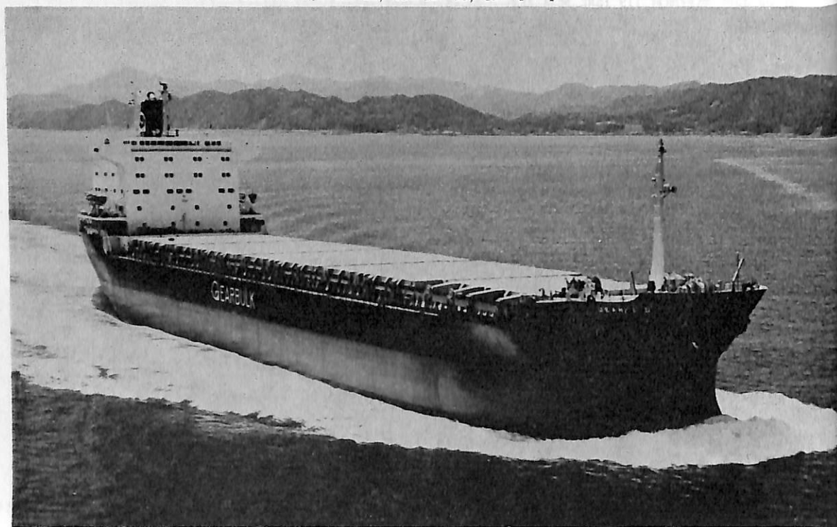
JEAN L.D (ばら積貨物船) 船主 S.A. Louis Dreyfus et Cie (フランス) 造船所 株式会社大阪造船所 総噸数 25,223.02噸 純噸数 13,528.63噸 遠洋 船級 BV 載貨重量 39,007噸 全長 182.00m 長(垂) 174.00 m 幅(型) 29.00m 深(型) 16.100m 吃水 11.604m 満載排水量 49,418噸 凹甲板船 主機 日立B&W 7 K74 EF型ディーゼル機関1基 出力 11,900PS×120RPM 燃料消費量 48.5t/d 航続距離 15,000海里 速力 14.5 ノット 汽罐 堅型横煙管式コンポジットボイラー1台 発電機 AC450V×60Hz×3φ 650KW×3台 貨物倉(ベ ール) 41,132.7m 3 (グレーン) 42,222.8m 3 清水倉 215.2m 3 燃料油倉 2,510.7m 3 乗員 38名 工期 48-11-29 49-2-27, 49-5-24
