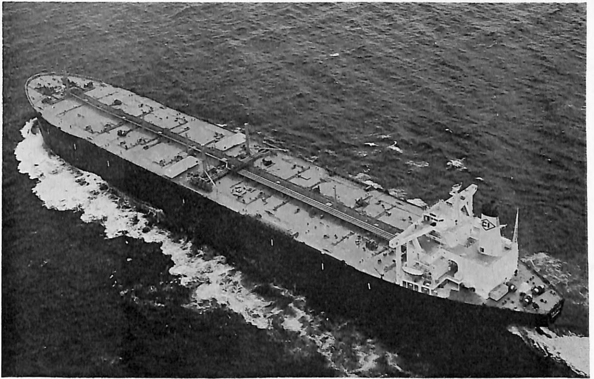
TACTIC (油槽船) 船主 Moon Tide Shipping Company S.A.(パナマ) 造船所 川崎重工業・坂出造船事業部 総噸数 105,365.35噸 純噸数 87,764.56噸 遠洋 船級 NK 載貨重量 233,341噸 全長 319.93m 長(噸) 305.00 m 幅(型) 53.00m 深(型) 25.30m 吃水 19.62m 満載排水量 268,038噸 平甲板型 主機 川崎UA360型船用 タービン 出力 35,000PS×89RPM 燃料消費量 173.8t/d 航続距離 15,380海里 速力 16.03ノット 汽罐 川 崎UMG72/56UA型2 胴水管式2基 発電機 1,600KW 2,000KVA, AC 450Vタービン駆動×1 760KW 950KVA AC 450Vディーゼル駆動×2 貨油倉 287,860.43m 3 燃料油倉 7,702.88m 3 清水倉 699.48m 3 乗員 41名 工期 48-9-25, 49-1-31, 49-5-24 設備 ノズルプロペラ装備
