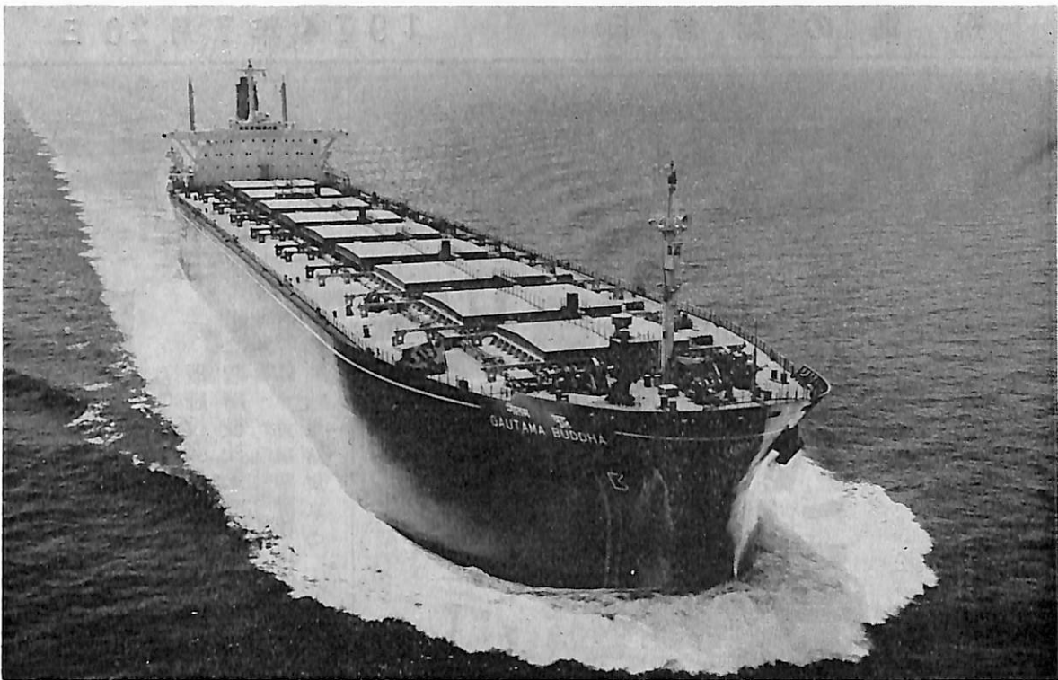
GAUTAMA BUDDHA (ばら積貨物船) 船主 The Shipping Corporation of India Ltd (インド) 造船所 三菱重工業・広島造船所 総噸数 72,759.11噸 純噸数 46,593.38噸 遠洋 船級 AB 載貨重量 129,513噸 全長 261.00m 長(垂) 247.00m 幅(型) 40.60m 深(型) 24.00m 吃水 17.608m 満載排水量 150,621噸 平甲板船 主機 三菱スルザー 9 RND90型ディーゼル機関1基 出力 23,490PS×118RPM 燃料消費量 85t/d 航続距離 25,300海里 速力 15.60ノット 汽罐 三菱コクラン型×1 発電機 AC450V×962.5KVA×3 貨物倉(グリーン) 140,212m 3 清水倉 1,265.3m 3 燃料油倉 7,271m 3 乗員 70名 工期 48-11-14, 49-2-13, 49-5-24
