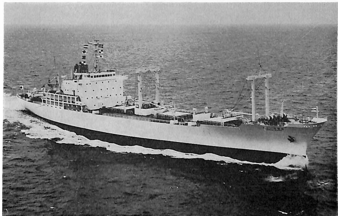
田りいふあ (冷凍貨物船) 船主 流通海運株式会社 造船所 尾道造船株式会社 総噸数 10,136.01噸 純噸数 5,902.99噸 遠洋 船級 NK 載貨重量 10,704.34噸 全長 162.80m 長(垂)152.00 m 幅(型) 22.60m 深(型) 13.50m 吃水 9.022m 満載排水量 17,352.48噸 船首楼付平甲板型 主機 日立 B &W 6 K84EF型ディーゼル機関1基 出力 14,000PS×110RPM 燃料消費量 53.5t/d 速力 20.4ノット 汽 罐 立門罐型 発電機 AC450V, 60Hz 1,000kW×3 貨物倉(ベール) 12,514.78m 3 清水倉 324.05m 3 燃料油倉 2,124.33m 3 乗員 30名 工期 48-8-31, 48-12-1, 49-3-28
