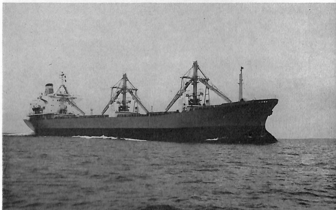
ASTIR (貨物船) 船主 Kitheron Shipping Co., S.A. (ギリシヤ) 造船所 石川島播磨重工業・東京工場 総噸数 13,632.93噸 純噸数 9,831.00噸 遠洋 船級 AB 載貨重量 22,669噸 全長 164.33m 長(垂) 155.448 m 幅(型) 22.86m 深(型) 13.56m 吃水 9.848m 平甲板型 主機 IHI-SEMT ビールスチック16PC-2V型 ディーゼル機関1基 出力 7,200PS×482RPM 燃料消費量 33.7t/d 航続距離 15,000海里 速力 15.0ノット 発電機 AC310KW×60Hz 450V×2 貨物倉(ベール) 29,950.9m 3 (グリーン) 30,907.0m 3 清水倉 201.4m 3 燃 料油倉 1,540m 3 乗員 27名 工期 48-12-12, 49-2-21, 49-4-30
