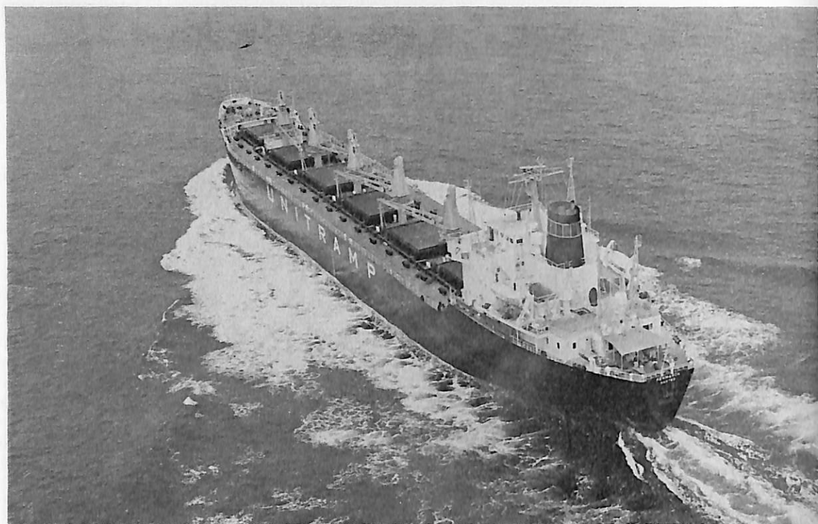
PENMARCH (ばら積貨物船) 船主 Societe Francaise de Trunport Maritimes (仏) 造船所 日本鋼管・清水造船所 総噸数 16,245.78噸 純噸数 10,177.43噸 遠洋 船級 BV 載貨重量 27,243噸 全長 174.692m 長(垂) 164.592m 幅(型) 22.86m 深(型) 14.707m 吃水 10.97m 満載排水量 34,060噸 凹甲板船 主機 住友スルザー6 RND76型ディーゼル機関1基 出力 10,800PS×118RPM 燃料消費量 43.13t/d 航続距離 13,600海里 速力 15.0ノット 汽罐 堅型煙管式 発電機 500KW×AC450V×3 貨物倉(ベール) 29,365m 3 (グリーン) 35,854m 3 清水倉 200m 3 燃料油倉 1,855m 3 乗員 32名 外2名 工期 48-10-29, 49-2-20, 49-5-31 設備 KaMeWa パウスラスター
