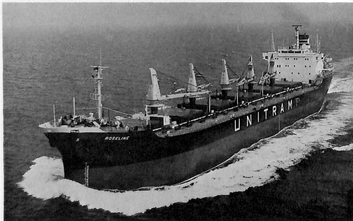
ROSELINE (ばら積貨物船) 船主 Union Industrielle Et Maritime (仏) 造船所 日本鋼管・清水造船所 総噸数 16,245.78噸 純噸数 10,177.43噸 遠洋 船級 BV 載貨重量 27,243噸 全長 174.692m 長(垂) 164.592m 幅(型) 22.86m 深(型) 14.707m 吃水 10.97m 満載排水量 34,060噸 凹甲板船 主機 住友スルザー6 RND76型ディーゼル機関1基 出力 10,800PS×118RPM 燃料消費量 43.13t/d 航続距離 13,600海里 速力15.0ノット 汽罐 堅型煙管式 発電機 500KW×AC450V×3 貨物倉(ベール) 29,365m 3 (グリーン) 35,854m 3 清水倉 200m 3 燃料油倉 1,855m 3 乗員 32名, 外2名 工期 48-12-24, 49-3-20, 49-6-25
