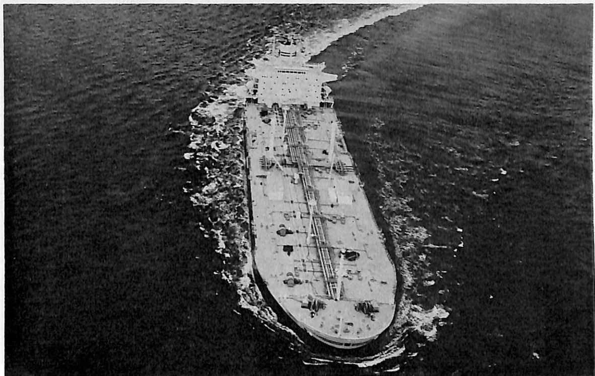
DACIA (油槽船) 船主 Navimpex-Galati (ルーマニア) 造船所 石川島播磨重工業・相生工場 総噸数 46,900.05噸 純噸数 30,848.25噸 遠洋 船級 LR 載貨重量 86,097噸 全長 242.11m 長(垂) 230.00 m 幅(型) 40.00m 深(型) 18.00m 吃水 13.608m 平甲板船 主機-IHIスルザー7RND90型ディーゼル機関 1基 出力 18,270PS×117.8RPM 燃料消費量 67.0t/d 航続距離 17,000海里 速力 15.70ノット 汽罐 IHI -2DWT-ADM 3215×2 発電機 AC 760KW×60Hz×450V×3 貨油倉 105,341.6m 3 清水倉 412.9m 3 燃料油 倉 3,637m 3 乗員 40名外5名 工期 48-9-7, 48-11-9, 49-4-5
