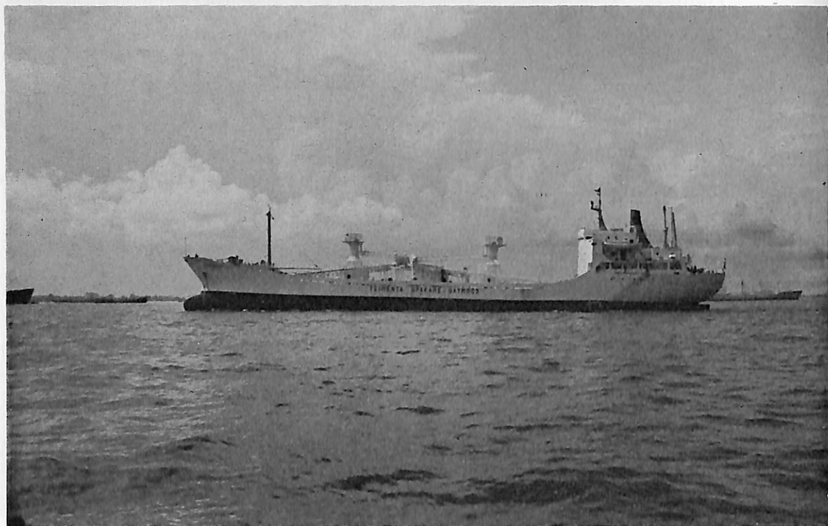
THESEUS (セメント運搬船) 船主 General Cement Co. S. A. (ギリシャ) 造船所 福岡造船株式会社 総噸数 3,735.10噸 純噸数 1,990.35噸 遠洋 船級 BV 載貨重量 6,507.68噸 全長 112.43m 長(垂) 102.73 m 幅(型) 16.60m 深(型) 8.40m 吃水 6.889m 満載排水量 8,905.00噸 凹甲板型 主機 IHI SEMT ピール スチック 6 PC 2L 型ディーゼル機関×2基 2軸 出力 2×1,955PS×473.5/244.7RPM 燃料消費量 14.3t/d 航 続距離 5,000海里 速力 13.6ノット 温水器 立型油焚式×1(120,000kcal/h) 電気式×1(8KW) 発電機 AC310K VA×380V×3 貨物倉 セメント艙 5,605.15m 3 清水倉 61.68m 3 燃料油倉 523.10m 3 乗員 29名 工期 48-9 -28, 49-1-14, 49-4-30 設備 セメント荷役装置, 機関室無人化装置
