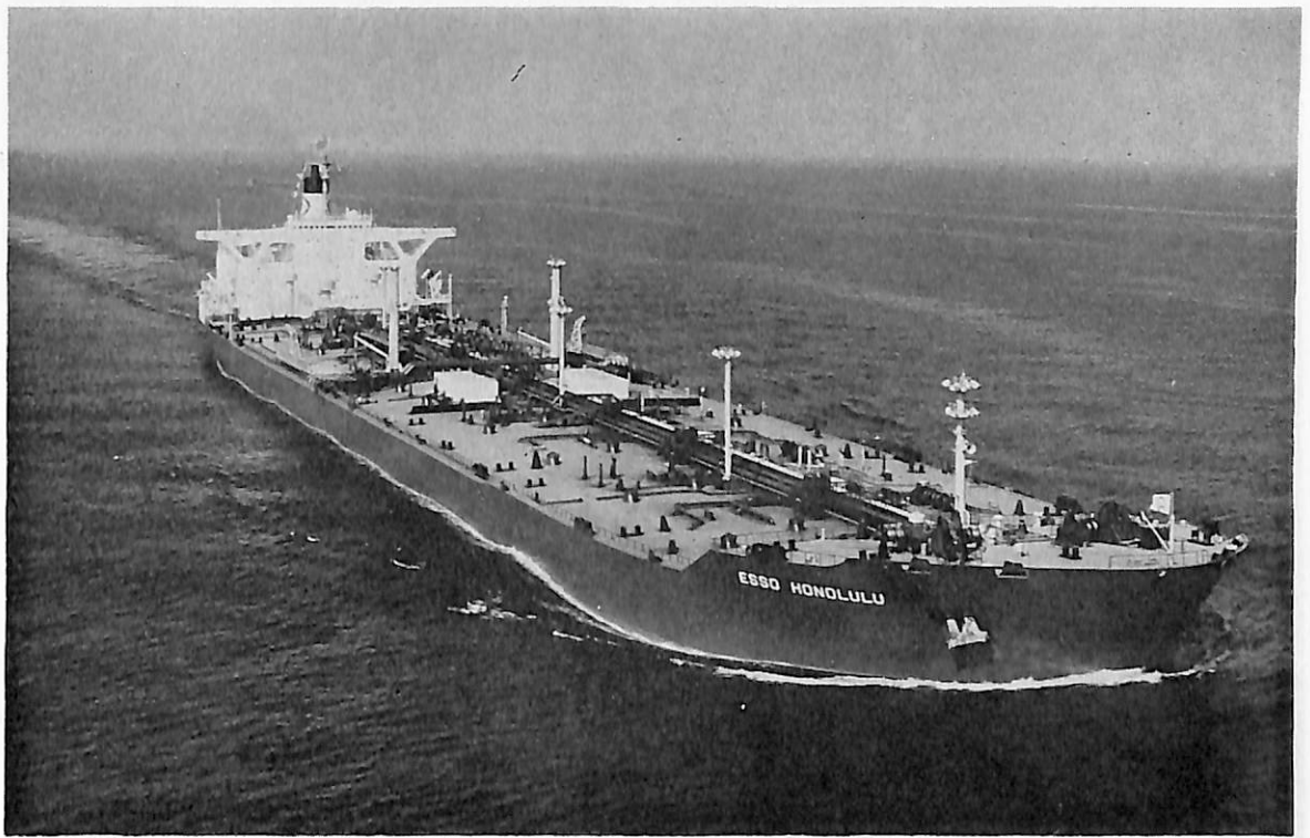
ESO HONOLULU (油槽船) 船主 Esso Tankers Inc. (リベリア) 造船所 日立造船・堺工場 総噸数 132,998.74噸 純噸数 112,665噸 遠洋 船級 AB 載貨重量 278,922Lt 全長 343.00m 長(垂)325.00 m 幅(型) 53.00m 深(型) 23.80m 吃水 22.059m 満載排水量 319,249Lt 一層甲板船 主機 日立UA-360 型タービン×1 出力 35,000PS×81RPM 燃料消費量 178.0t/d 航続距離 29,000海里 速力 15.25ノット 汽罐 日立UMC72/55型 27,000kg/h×2 発電機 2,100KW, AC450V×1,800rpm×2 貨油倉 341,012.1m 3 清水 倉 781.4m 3 燃料油倉 15,427.7m 3 乗員 50名 工期 48-9-25, 49-3-1, 49-6-14
