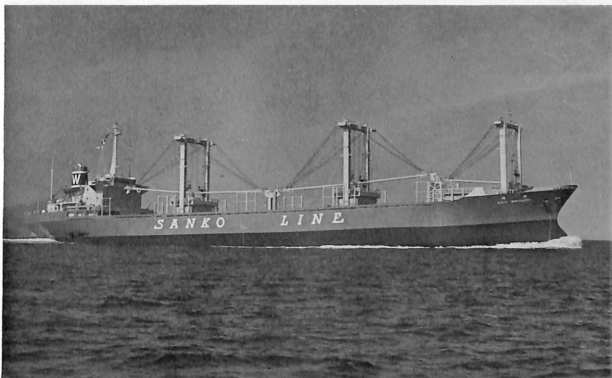
ASIA BRAVERY (貨物船) 船主 Liberian Sterculia Transports Inc. (リベリア) 造船所 株式会社神田造 船所 総噸数 15,016.76噸 純噸数 10,846.21噸 遠洋 船級 NK 全長 175.84m 長(垂) 165.00m 幅(型) 25.40m 深(型) 13.40m 吃水 9.623m 満載排水量 32,541.82噸 凹甲板型 主機 IHIスルザー6RND68型ディ ーゼル機関1基 出力 8,910PS×144.8RPM 燃料消費量 35.6t/d 航続距離 15,300海里 速力 14.6ノット 汽 罐 ガテリウスサンロッドCPDB15型1基 発電機 445V×701A×432KW 貨物倉(ベール) 30,874.17m 3 (グレ ーン) 32,472.56m 3 清水倉 377.44m 3 燃料油倉 1,868.85m 3 乗員 34名 工期 48-11-20, 49-3-13, 49- 6-19
