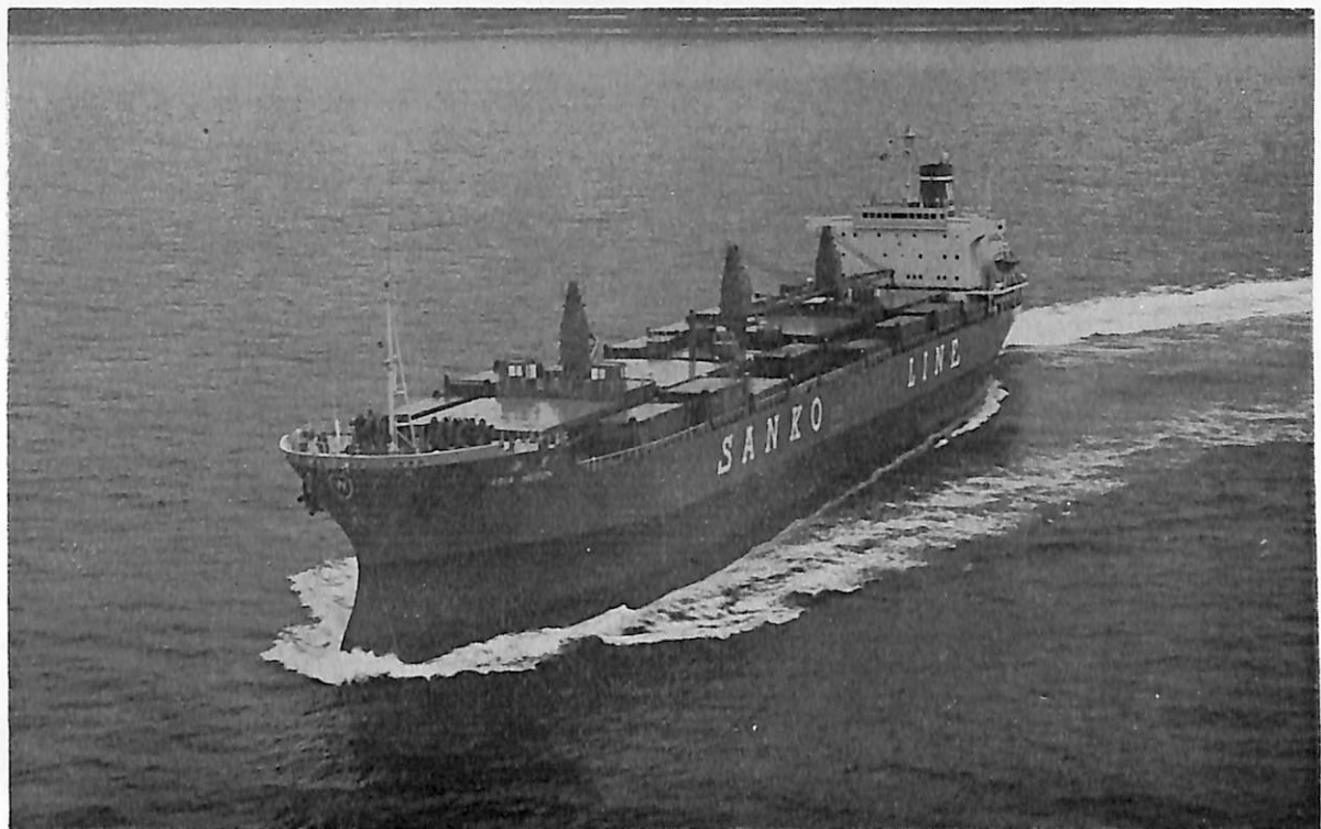
ASIA HERON (自動車兼ばら積貨物船) 船主 Liberian Heron Transports, Inc. (リベリア) 造船所 株式会社大阪造船所 総噸数 20,513.25噸 純噸数 14,481噸 遠洋 船級 AB 載貨重量 33,092噸 全長 185.371m 長(垂) 175.00m 幅(型) 26.00m 深(型) 16.10m 吃水 11.385m 満載排水量 42,732噸 船首楼付平甲板船 主機 IHIスルザー6RND76型ディーゼル機関1基 出力 10,800PS×117.8RPM 燃料消費量 43.25t/d 航続距離 15,600海里 速力 14.8ノット 汽罐 コンポジットボイラー7kg/cm 2 1台 発電機 AC 450V 500KVA 3台 貨物倉(ベール) 40,088m 3 (グリーン) 41,396m 3 清水倉 465.4m 3 燃料油倉 2,137.9m 3 乗員 38名 工期 49-1-18, 49-4-19, 49-6-28 吊下式, 取外し式自動車甲板を第1.2.3.4.5 ホールドに設置
