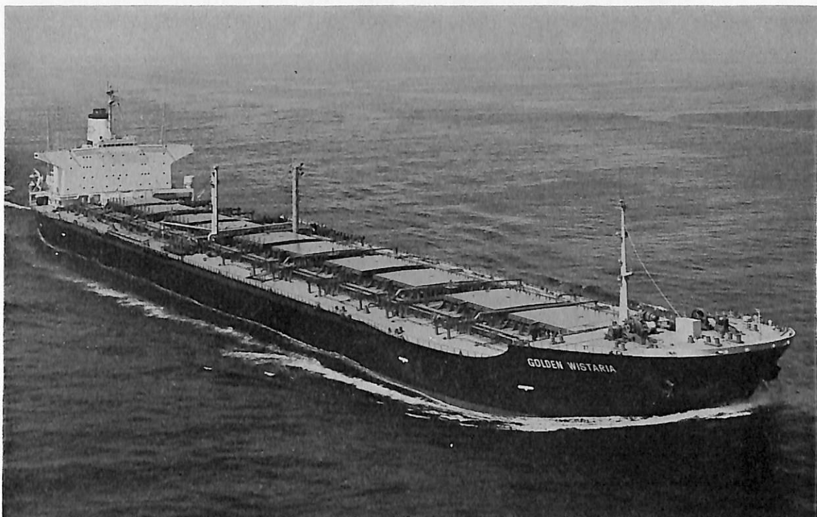
GOLDEN WISTARIA (鉱石兼油槽船) 船主 Camelia S. A. (パナマ) 造船所 川崎重工業・神戸工場 総噸数 77,872.62噸 純噸数 63,817.21噸 遠洋 船級 NK 載貨重量 157,675噸 全長 289.00m 長(垂)275.00 m 幅(型) 44.00m 深(型) 24.20m 吃水 17.956m 満載排水量 187,304噸 船首樓付平甲板船 主機 川崎MA NK8SZ105/180型ディーゼル機関1基 出力 27,200PS×100RPM 燃料消費量 97.4t/d 航続距離 33,400海 里 速力・15.62ノット 汽罐 船用乾燃室式円ボイラー1基 発電機 1,500KVA×2 貨物倉 鉱石倉 86,355.3m 3 貨物油タンク 194,668.9m 3 燃料油倉 10,408.5m 3 清水倉 484.5m 3 乗員 36名 工期 48-9-6, 49-3-28 49-6-24
