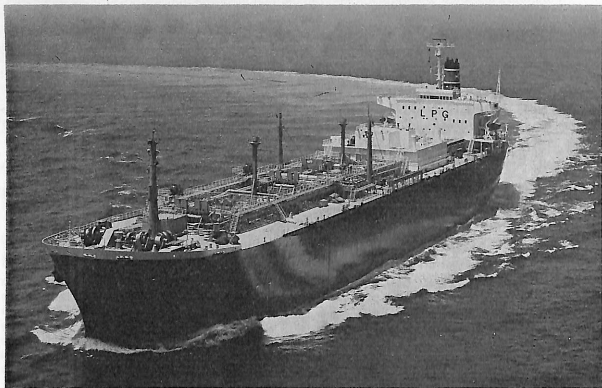
徳 邦 丸 (LPG運搬船) 船主 飯野海運株式会社 造船所 三井造船・玉野造船所 総噸数 39,117.38噸 純噸数 23,730.45噸 遠洋 船級 NK 載貨重量 38,823噸 全長 215.000m 長(垂)203.000 m 幅(型) 32.000m 深(型) 21.500m 吃水 11.110m 満載排水量 23,730.45噸 平甲板船 主機 三井B&W 6 K 84EF型ディーゼル機関1基 出力 13,200PS×108RPM 燃料消費量 50.5t/d 航続距離 17,750海里 速力 16.08ノット 汽罐 横煙管ボイラー 2,000kg/hr×7 kg/cm 2 G×1 発電機 670KW×2 貨油倉 61,203.066m 3 清水 倉 342.9m 3 燃料油倉 FO 2,544.1m 3 DO 399.6m 3 乗員 46名 工期 48-9-14, 48-12-26, 49-6-24
