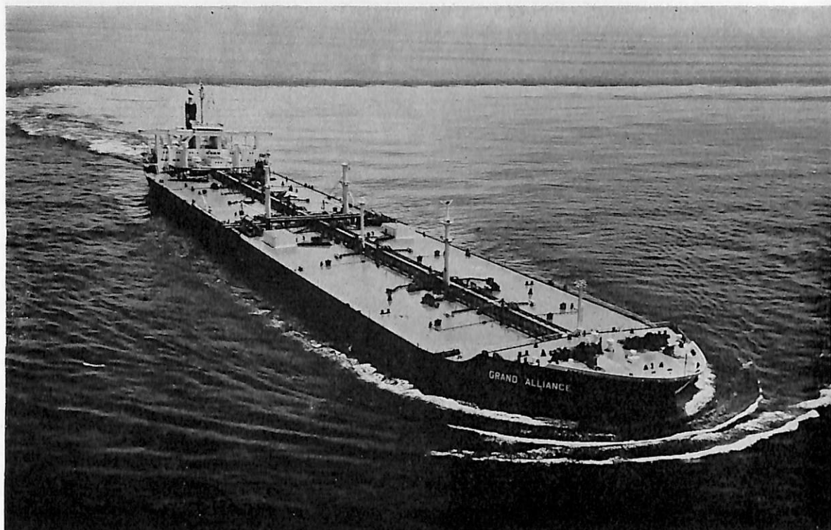
GRAND ALLIANCE (油槽船) 船主 Grand Bassa Tankers Inc.(英) 造船所 三菱重工業・長崎造船所 総噸数 118,215.56噸 純噸数 100,269噸 遠洋 船級 AB 載貨重量 264,018噸 全長 338.629m 長(垂)320.00 m 幅(型) 53.60m 深(型) 26.40m 吃水 67' - 5 \frac{1}{8} " 平甲板船 主機 三菱2段減速装置付タービン 出力34,000 PS×99RPM 燃料消費量 165t/d 航続距離 25,000海里 速力 15.4ノット 汽罐 三菱CE-V2M-8W型×2 発電機 AC450V 1,600KW×1 貨油倉 320,552.1m 3 清水倉 372.5m 3 燃料油倉 12,239.0m 3 乗員 47名 工期 48 -10-26, 49-1-24, 49-6-6
