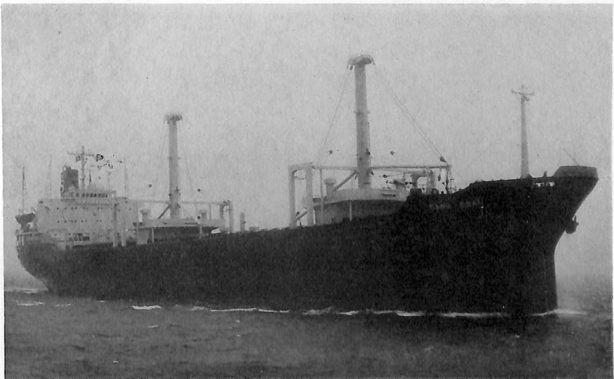
CAPE ESAN (貨物船) 船主 Taurus Transportation Co., Ltd. (パナマ) 造船所 檣崎造船株式会社 総噸数 10,055.52噸 純噸数 5,997.75噸 遠洋 船級 NK 載貨重量 16,150.6噸 全長 139.96m 長(垂) 129.50m 幅(型) 21.40m 深(型) 12.55m 吃水 9.535m 満載排水量 20,856.9噸 凹型二層甲板 主機 赤坂鉄工 UE C52/105D型ディーゼル機関1基 出力 6,800PS×166RPM 燃料消費量 26.78t/d 航続距離 15,313海里 速力 13.75ノット 発電機 360KVA×AC445V×60Hz×2 貨物倉(ベール) 19,024.4m 3 (グリーン) 20,782.4m 3 清水倉 412.4m 3 燃料油倉 1,520.2m 3 乗員 40名 工期 48-12-10, 49-3-9, 49-5-30
