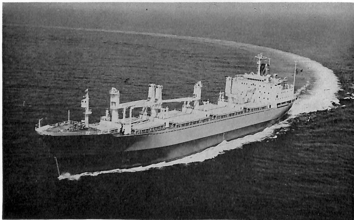
OCEAN ENERGY (貨物船) 船主 Peace Enterprises and Shipping Company (リベリア) 造船所 三菱重工業・下関造船所 総噸数 13,687.10噸 純噸数 8,026噸 遠洋 船級 AB 載貨重量 19,922Lt 全長 163.72m 長(垂) 152.00m 幅(型) 22.86m 深(型) 14.40m 吃水 10.738m 満載排水量 27,004Lt 船首楼付平甲板船 主機 三菱スルザー6 RND76型ディーゼル機関1基 出力 10,800 \text{PS} \times 118 \text{RPM} 燃料消費量 39.2t/d 航続距離 1,820海里 速力 17.60ノット 汽罐 コクラン型 7 \text{kg/cm}^2 \times 1,200 \text{kg/h} \times 1 発電機 620KVA, AC 450V, 60Hz \times 3 貨物倉(ペール) 26,658.5m 3 (グレーン) 28,380.1m 3 清水倉 350m 3 乗員 50名 工期 48-11-26, 49-3-9, 49-7-10
