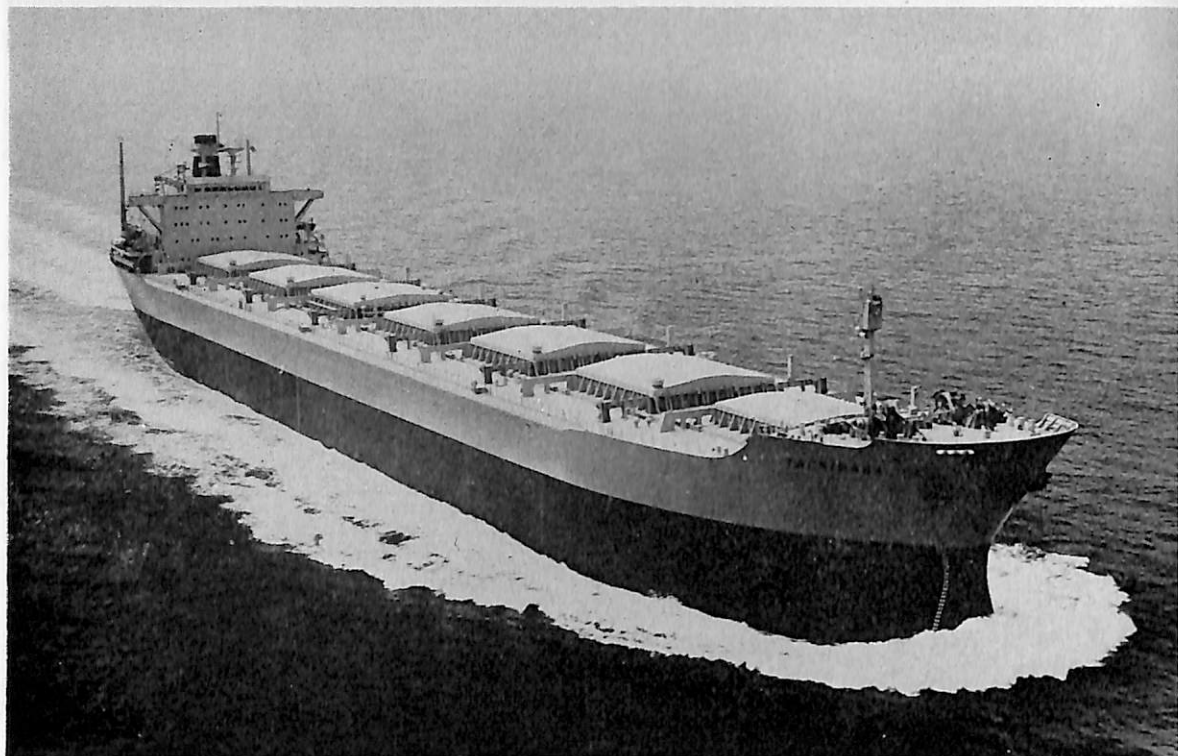
TACHIBANA (ばら積貨物船) 船主 Skipsaktieselskapet Triton (ノルウェー) 造船所 三菱重工業・神戸 造船所 総噸数 36,242.887噸 純噸数 23,324.67噸 遠洋 船級 NV 載貨重量 63,550Lt 全長 224.60m 長 (垂) 211.28m 幅(型) 31.80m 深(型) 18.35m 吃水 13.242m 満載排水量 75,315Lt 船首楼付平甲板船 主機 三菱スルザー7KND76型ディーゼル機関1基 出力 12,600PS×118RPM 燃料消費量 46.2t/d 航続距 離 22,000海里 速力 14.6ノット 発電機 AC 450V×60Hz×500KVA×3 貨物倉(グレーン) 76,315.0m 3 清水 倉 543.8m 3 燃料油倉 3,605.1m 3 工期 48-9-6, 49-5-13, 49-7-12 設備 機関部自動化
