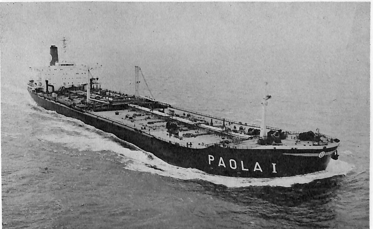
PAORA I (油槽船) 船主 Union Tankers Corporation. (リベリア) 造船所 住友重機械工業・浦賀造船所 総噸数 65,067噸 船級 AB 載貨重量 139,390Lt 長(垂) 258.00m 幅(型) 44.00m 深(型) 22.90m 吃水 17.00m 主機 住友スルザー9 RND90型ディーゼル機関1基 出力 26,000PS×122RPM 速力 16.0ノット 工 期 48-11-26, 49-3-7, 49-6-14 備考 住友 138型スタンダード型第2船
