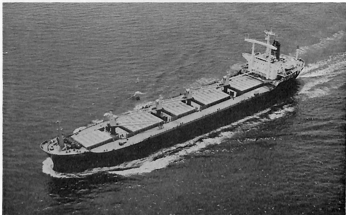
ASIA FALCON (ばら積貨物船) 船主 Liberian Bauhinia Transports Inc. (リベリア) 造船所 住友重機工業・浦賀造船所 総噸数 18,394.45噸 船級 BV 載貨重量 34,659噸 長(垂) 170.00m 幅(型) 28.40m 深(型) 15.00m 吃水 10.84m 主機 住友スルザー 6 RND76型ディーゼル機関 1基 出力 12,000PS×122RPM 速力 15.0ノット 工期 48-10-25, 49-3-23, 49-6-25
