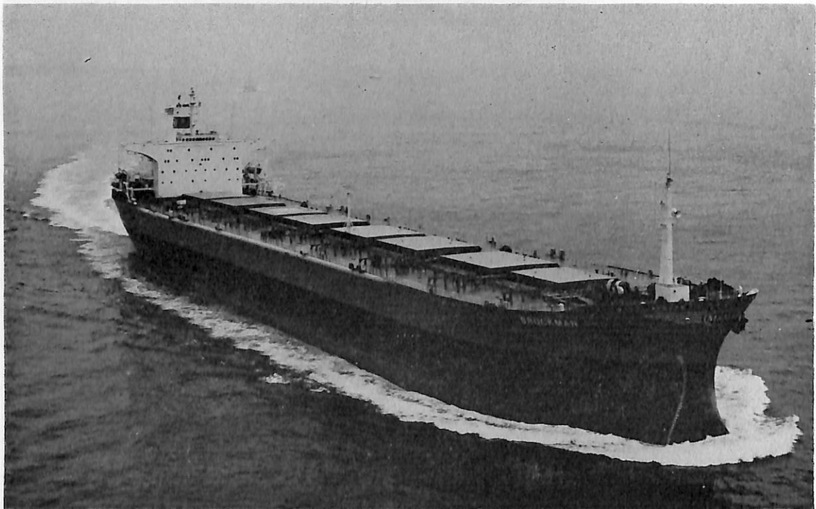
BROCKMAN (鉱石運搬船) 船主 Merchants & Miners Transport Inc. (リベリア) 造船所 三井造船・玉野造船所 総噸数 33,938.45噸 純噸数 21,497噸 遠洋 船級 AB 載貨重量 116,342噸 全長 259.347m 長(垂) 249.000m 幅(型) 39.60m 深(型) 22.00m 吃水 16.151m 満載排水量 136,311噸 平甲板船 主機 三井B&W 9 K84EF型ディーゼル機関1基 出力 21,100BPS×110RPM 燃料消費量 76t/d 航続距離 30,000海里 速力 15.55ノット 汽罐 船用乾熱室丸ボイラ 11,000kg/hr×8.5kg/cm 2 ×1 発電機 560KW×2, 1,100KW×1 貨物倉(グレーン) 66,022.9m 3 清水倉 768.4m 3 燃料油倉 FO 6,932.7m 3 DO 326.3m 3 乗員 35名 工期 48-12-14, 49-3-12, 49-6-28
