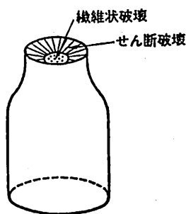
図 9-5 Cup and cone 型破壊
