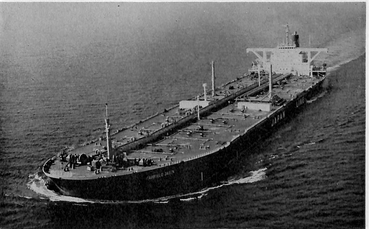
FAIRFIELD JASON (油槽船) 船主 Fairway Tankers. (リベリア) 造船所 住友重機械工業・追浜造船所 総噸数 122,222.44噸 船級 AB 載貨重量 275,977噸 長(垂) 324.00m 幅(型) 54.40m 深(型) 26.90m 吃 水 20.96m 主機 住友スタルラバルAPタービン×1 出力 38,000PS×91RPM 工期 48-11-26, 49-3- 15, 49-7-4
