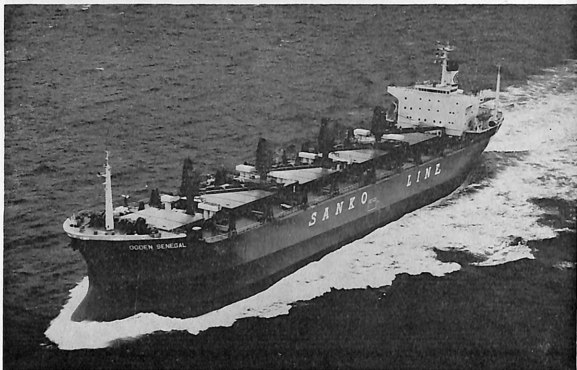
OGDEN SENEGAL (自動車兼ばら積貨物船) 船主 Ogden Niger Transport Inc. (リベリア) 造船所 佐野安船渠株式会社 総噸数 20,711.86噸 遠洋 船級 BV 載貨重量 38,011噸 全長 180.64m 長(垂) 170.00m 幅(型) 27.60m 深(型) 17.60m 吃水 12.711.86m 凹甲板型 主機 住友スルザー 7 RND76型ディーゼル機関 1基 出力 14,000PS×122RPM 航続距離 17,000海里 速力 15.1ノット 汽罐 1,500kg/h×7 kg/cm 2 G×1 発電機 550KVA×AC450V×3 貨物倉(ペール) 41,011.8m 3 (グリーン) 42,254.8m 3 自動車搭載 2,172台 乗員 39名 工期 49-1-26, 49-5-11, 49-7-30 設備 カーデッキ面積 計 17,000m 2
