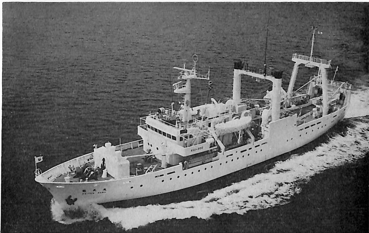
敬 天 丸 (漁業練習船) 船主 文部省 造船所 内海造船株式会社 田熊工場 総噸数 854.55噸 純噸数 252.69噸 遠洋 船級 J G 載貨重量 697.23噸 全長 61.90m 長(垂) 55.00m 幅(型) 11.00m 深(型) 4.70m/6.90m 吃水 4.50m 満載排水量 1,741噸 全通船楼船(船尾トロール) 主機 ダイハツ 4サイクル中速過給機付ディーゼル機関1基 出力 2,000PS×600/270RPM 常用翼角 20° 燃料消費量 8.3 t/d 航続距離 10,608海里 速力 13.0ノット 汽罐 4 kg/cm 2 G×330kg/h×1台 発電機 AC 450V×375KVA (300KW)×2 漁倉(ペール) 74.55m 3 清水倉 77.81m 3 燃料油倉 330.85m 3 乗員 乗組員 31名 教官 3名 学生 40名 工期 48-10-27, 49-2-25, 49-7-5
