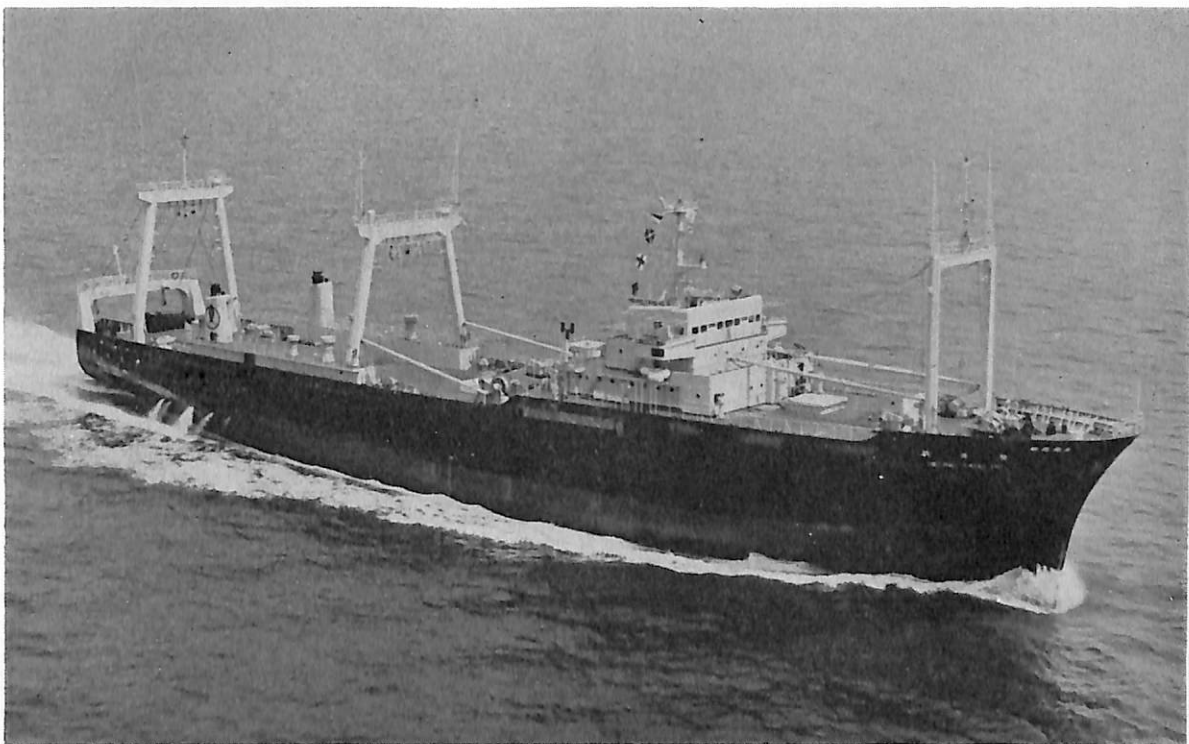
HEUNG YANG HO (興洋號) (トロール漁船) 船主 高麗遠洋漁業株式会社 (韓) 造船所 林兼造船・長崎造船所 総噸数 5,377.04噸 純噸数 2,797.83噸 第3種漁船 船級 KR及びNK 載貨重量 5,200.99噸 全長 112.09 m 長(垂) 101.95m 幅(型) 17.00m 深(型) 11.20m 吃水 7.267m 満載排水量 8,817.98噸 長船首楼付平甲板型 主機 神発 8 UET 45/80D型ディーゼル機関1基 出力 4,930PS×218RPM 燃料消費量 18.73t/d 航続距離 24,000海里 速力 13.75ノット 汽罐 水管式×1 発電機 AC 450 800KW×3 冷凍魚倉 3,462.85m 3 フィッシュミール倉 994.91m 3 清水倉 90.83m 3 燃料油倉 A 1,500.30m 3 C 686.95m 3 乗員 160名 工期 49-2-8, 49-4-9, 49-7-15 設備 フィッシュミール製造設備(魚油製造装置付) フィレー製造設備
