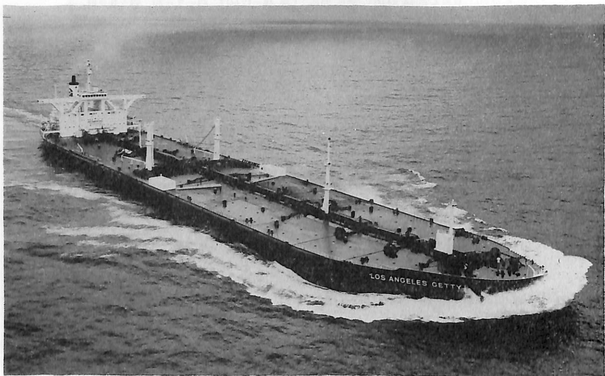
LOS ANGELES GETTY (油槽船) 船主 Hemisphere Transportation Corp. (リベリア) 造船所 三菱重工 業・長崎造船所 総噸数 101,416.83噸 純噸数 83,377噸 遠洋 船級 AB 載貨重量 223,716噸 全長 320.00m 長(垂) 304.00m 幅(型) 52.40m 深(型) 24.60m 吃水 62' - 6 \frac{1}{4} " 平甲板船 主機 三菱 2段減速装置付舶用 タービン1基 出力 30,000PS×88RPM 燃料消費量 147t/d 航続距離 16,300海里 速力 15.4ノット 汽罐 三菱CE-V2M型×2 発電機 AC 450×550KW×1,800rpm×1 貨油倉 277,617.0m 3 清水倉 603.7m 3 燃料油 倉 7,272.1m 3 乗員 39名, 外3名 工期 48-12-19, 49-3-27, 49-7-2 同型船 J. PAUL GETTY
