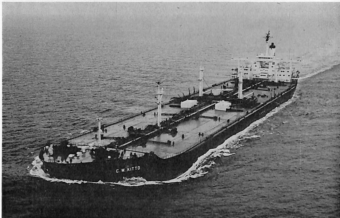
C.W. KITTO (油槽船) 船主 Chevron Navigation Corpration (リベリア) 造船所 三菱重工業・長崎造船所 総噸数 118,218.17噸 純噸数 100,282噸 遠洋 船級 AB 載貨重量 264,108噸 全長 338.629m 長(垂) 320.00 m 幅(型) 53.60m 深(型) 26.40m 吃水 67' - 5 \frac{3}{4} " 船首楼付平甲板船 主機 三菱 2段減速機付舶用タービン 1基 出力 34,000PS×90RPM 燃料消費量 165t/d 航続距離 25,300海里 速力 15.4ノット 汽罐 61.2kg/cm 2 ×72,000kg/h×2 発電機 1,500KW×AC 450V 1,800rpm×1 貨油倉 320,552.1m 3 清水倉 372.5m 3 燃料油倉 12,296.6m 3 乗員 40名, 予備 10名 工期 48-12-11, 49-3-8, 49-7-10
