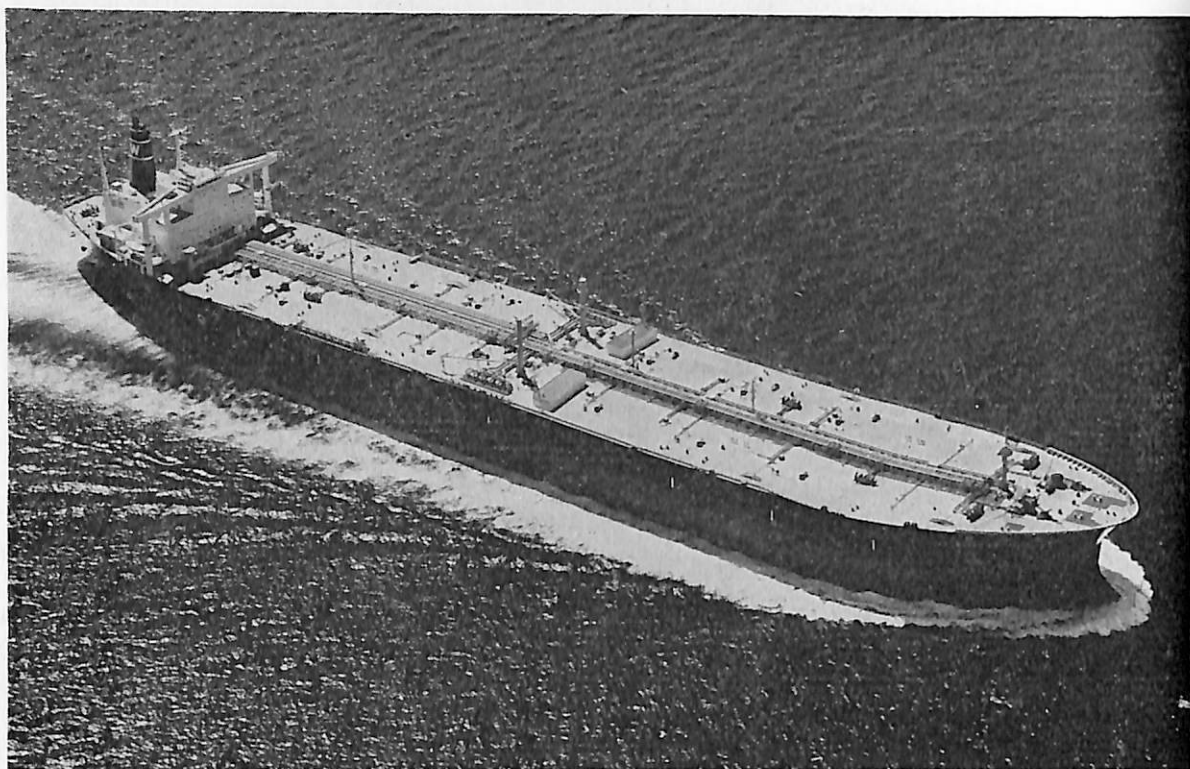
WORLD BRIGADIER (油槽船) 船主 Pine Shipping Company S.A. (パナマ) 造船所 川崎重工業・坂出造船事業部 総噸数 105,178.68噸 純噸数 87,761.10噸 遠洋 船級 NK 載貨重量 233,348噸 全長 319.93m 長(垂) 305.00m 幅(型) 53.00m 深(型) 25.30m 吃水 19.653m 満載排水量 268,038噸 平甲板型 主機 川崎UA-360 2段減速齒車装置付船用タービン1基 出力 35,000PS×89RPM 燃料消費量 171.9t/d 航続距離 16,000海里 速力 16.64ノット 汽罐 川崎UMG70/56-UA2 胴水管式2基 発電機 1,600KW 2,000KVA, AC. 450V×1 760KW 950KVA, A.C 450V×2 燃料油倉 7,702.88m 3 清水倉 201.15m 3 乗員 43名 工期 48-11-14, 49-3-15, 49-7-10 設備 ノズルプロペラ装備
