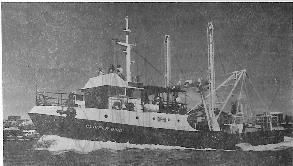
オーストラリアの CARRINGTON 社において 1973 年に建造された CLIPPER BIRD 号。同船は (株) 極洋の現地合弁会社 G.K.F.C 社が日本船方式の考え方を採り入れて、現地にて設計、建造されたえびトロール船である。トロール・ウィンチ、航海計器等は日本より輸入した。
