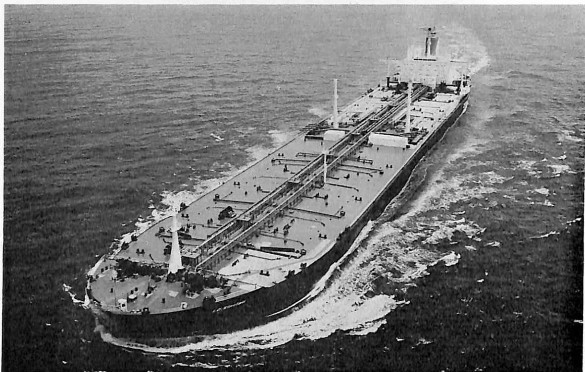
I.D. SINCLAIR (油槽船) 船主 Canadian Pacific Steamships Ltd. (Bermuda) 造船所 日本鋼管・津造船所 総噸数 133,678.83噸 純噸数 98,563.71噸 遠洋 船級 LR 載貨重量 254,691噸 全長 338.1m 長(垂) 320.0m 幅(型) 51.8m 深(型) 26.7m 吃水 20.575m 満載排水量 294,306噸 船首楼付平甲板船 主機 三井 B & W10K90GF型ディーゼル機関1基 出力 30,000PS×109.2RPM 燃料消費量 111t/d 航続距離 29,000海里 速力 15.327ノット 汽罐 50,000kg/h×22kg/cm 2 GSAT 発電機 1,080KW×450V×2 1,600KW×450V×1 貨油倉 310,046.8m 3 清水倉 749.4m 3 燃料油倉 9,467.4m 3 乗員 59名 工期 48-12-12, 49-3-29, 49-7-20
