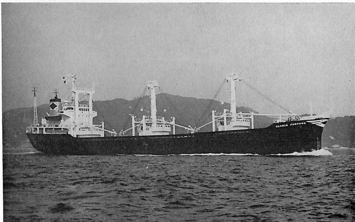
GLORIA FORTUNA (貨物船) 船主 Eastern Glory Marine Coporation S.A.(パナマ) 造船所 渡辺造船株式会社 総噸数 5,155.29噸 純噸数 3,377.99噸 遠洋 船級 BV 載貨重量 8,263.46噸 全長 117.90m 長(垂) 110.00m 幅(型) 18.00m 深(型) 9.00m 吃水 7.218m 満載排水量 11,139.69噸 凹甲板船 主機 神戸発動機 7 UET 45/80D型ディーゼル機関1基 出力 4,250PS×218RPM 燃料消費量 17.2t/d 航続距離 13,540海里 速力 13.000ノット 汽罐 622kg/hr×7 kg/cm 2 発電機 250KVA×445V×2 貨物倉(ベール) 10,569.20m 3 (グレーン) 11,185.80m 3 清水倉 814.98m 3 燃料油倉 785.18m 3 乗員 33名 工期 49-3-14, 49-6-4, 49-7-12
