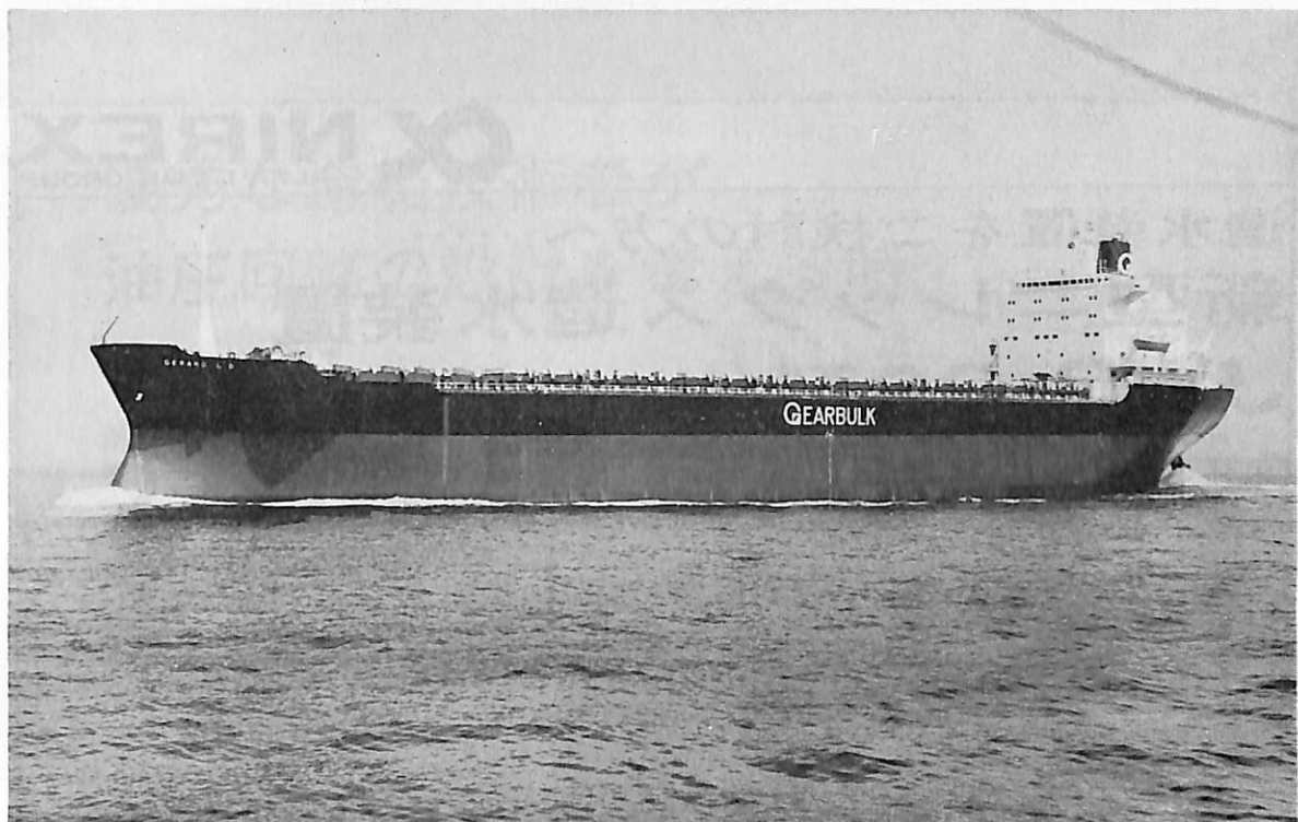
GERARD L.D. (ばら積貨物船) 船主 S. A. Louis Dreyfus Et Cie. (仏) 造船所 株式会社大阪造船所 総噸数 25,223.02噸 純噸数 13,528.63噸 遠洋 船級 BV 載貨重量 39,007噸 全長 182.00m 長(垂) 174.00 m 幅(型) 29.00m 深(型) 16.10m 吃水 11.604m 満載排水量 49,418噸 凹甲板船 主機 日立B&W7K74E F型ディーゼル機関1基 出力 11,900PS×120RPM 燃料消費量 48.5t/d 航続距離 15,000海里 速力 14.5ノ ット 汽罐 堅型横煙管式コンポジットボイラー1基 発電機 AC450V×60Hz, 650KW×720rpm×3 貨物倉(ペー ル) 41,132.7m 3 (グレーン) 42,222.8m 3 清水倉 215.2m 3 燃料油倉 2,510.7m 3 乗員 38名 工期 49-2-27, 49-5-31, 49-8-13
