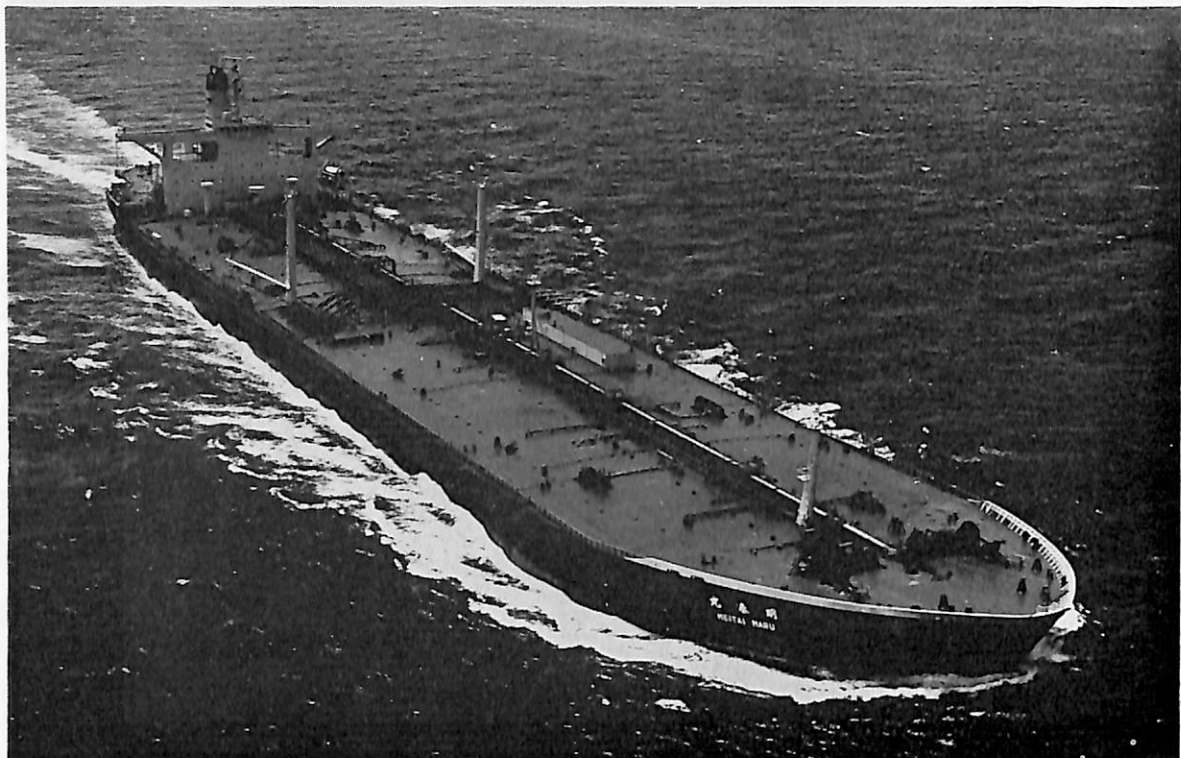
明 泰 丸 (油槽船) 船主 明治海運株式会社・東燃タンカー株式会社 造船所 三井造船・千葉造船所 総噸数 123,940.38噸 純噸数 89,550.17噸 速洋 船級 NK 載貨重量 234,240噸 全長 324.00m 長(垂) 310.00m 幅(型) 54.00m 深(型) 26.40m 吃水 19.5305m 満載排水量 269,214噸 平甲板型 主機 三井B & W10K98FF型ディーゼル機関1基 出力 32,300BHP×97.5RPM 燃料消費量 121t/d 航続距離 28,680海里 速力 16.08ノット 汽罐 三井2胴式モノウォール型水管1基 発電機 1,120KW×1 760KW×2 貨油倉 286,837.0 m 3 清水倉 648.8m 3 燃料油倉 9,913.3m 3 乗員 32名 工期 48-10-31, 49-4-29, 49-8-2, M0 取得船
