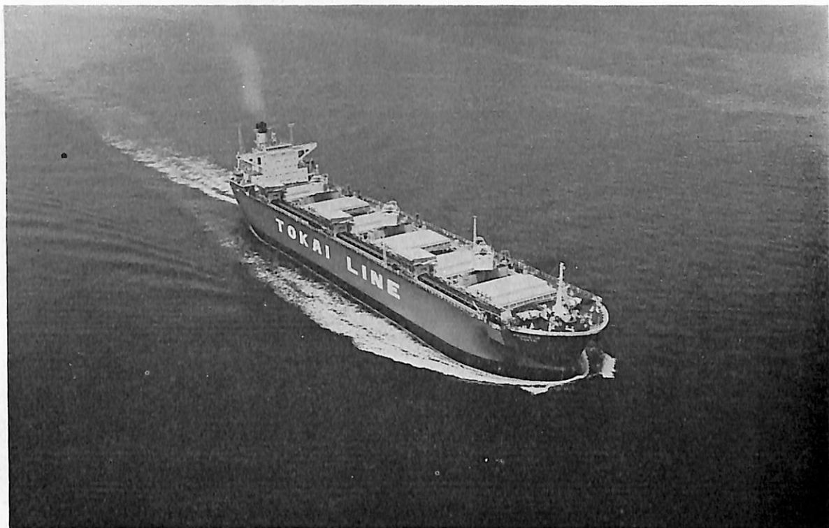
PRINCE OF TOKYO (チップ運搬船) 船主 Atlantic Glory Shipping Co., S. A. (リベリア) 造船所 来島ど っく・大西工場 総噸数 33,367.14噸 純噸数 25,282.03噸 遠洋 船級 NK 載貨重量 41,511.0噸 全長 194.70m 長(垂) 182.50m 幅(型) 30.40m 深(型) 21.30m 吃水 11.026m 満載排水量 52,763.0噸 平甲板 型 主機 川崎MAN K8 Z70/120E型ディーゼル機関1基 出力 10,540PS×133RPM 燃料消費量 41.27t/d 航 続距離 14,700海里 速力 13.9ノット 汽罐 乾燃室式丸ボイラー 1,500kg/h 発電機 600KVA, AC 450V×3 貨 物倉(グレーン) 83,546.0m 3 清水倉 1,091.96m 3 燃料油倉 2,033.96m 3 乗員 35名 工期 48-11-20, 49-3 -27, 49-7-11
