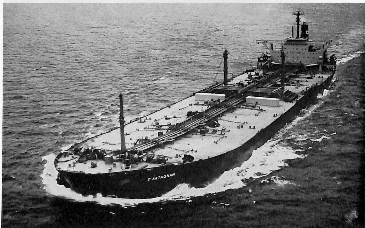
D'ARTAGNAN (油槽船) 船主 Mobil Oil Francaise (仏) 造船所 住友重機械工業・追浜造船所 総噸数 140,745噸 船級 BV 載貨重量 270,07Lt 長(垂) 324.00m 幅(型) 54.40m 深(型) 26.90m 吃水 20.96m 主機 住友スタルラバルAPタービン1基 出力 38,000PS×91RPM 工期 48-10-1, 49-1-21, 49-5-13
