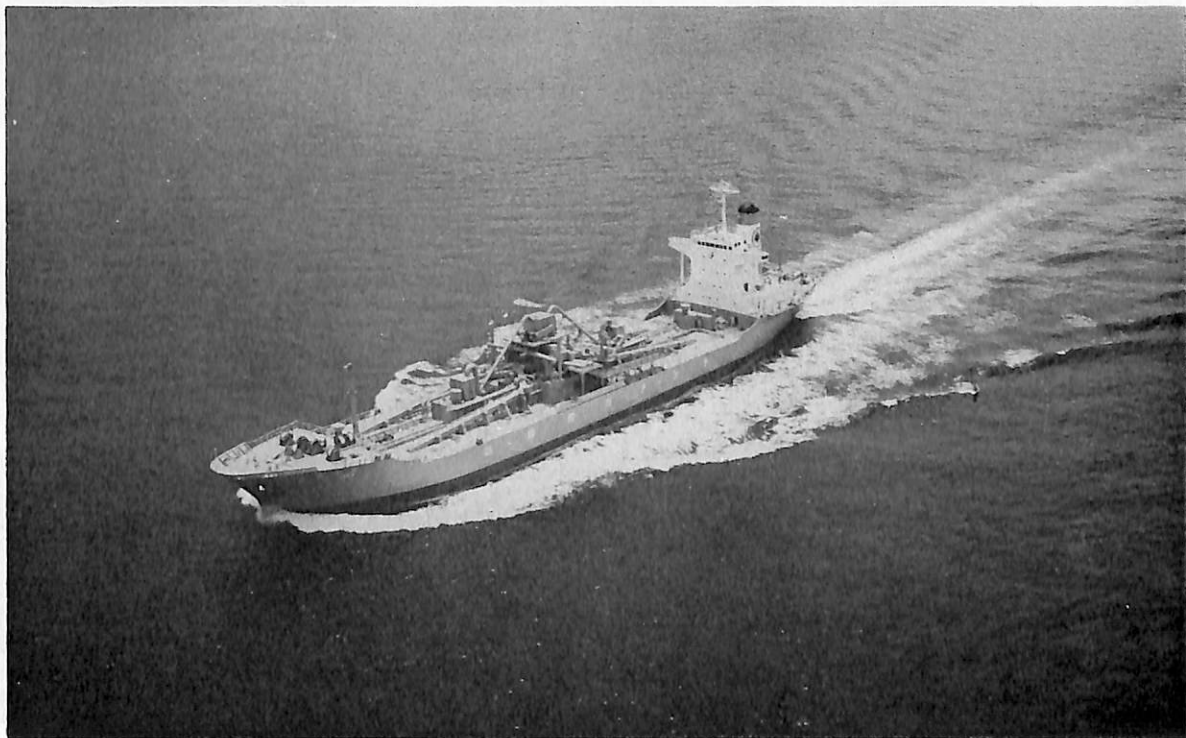
旺洋丸 (セメント運搬船) 船主 東海運株式会社 造船所 高知重工株式会社 総噸数 7,009.63噸 純噸数 3,733.75噸 沿海 船級 NK 載貨重量 11,328.74噸 全長 141.29m 長(垂) 130.04 m 幅(型) 20.00m 深(型) 10.00m 吃水 7.719m 満載排水量 15,532.68噸 主機 川崎重工MAN 4サイクル中 速トランクピストン型ディーゼル機関1基 出力 7,200PS×417/157RPM 燃料消費量 28.51t/d 航続距離 2,500海里 速力 15.0ノット 貨物倉(グレーン) 8,841.82m 3 清水倉 121.76m 3 燃料油倉 337.95m 3 乗員 28名 工期 49-2-2, 49-4-16, 49-7-28 セメント荷役: 積込設備能力 2,000t/h 荷揚能力(圧送式) 1,000t/h (機械式) 400t/h
