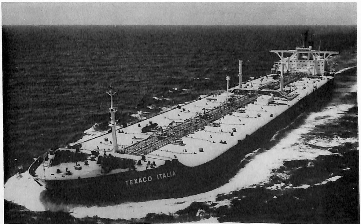
TEXACO ITALIA (油槽船) 船主 Texaco Panama Inc. (パナマ) 造船所 三菱重工業・長崎造船所 総噸数 123,647.50噸 純噸数 103,821.00噸 遠洋 船級 AB 載貨重量 267,837噸 全長 338.63m 長(垂) 320.00m 幅(型) 53.60m 深(型) 26.40m 吃水 20.5525m 船首樓付平甲板船 主機 三菱2段減速装置付船用タービン1基 出力 34,000PS×90RPM 燃料消費量 166t/d 航続距離 25,380海里 速力 15.4ノット 汽罐 三菱CE, V2M-8W型×2 61.5kg/cm 2 , 515°C 発電機 AC450V, 1,500KW×2 貨油倉 321,060.70m 3 清水倉 470.6m 3 燃料油倉 12,386.3m 3 乗員 36名, 外6名 工期 48-12-17, 49-4-13, 49-8-14
