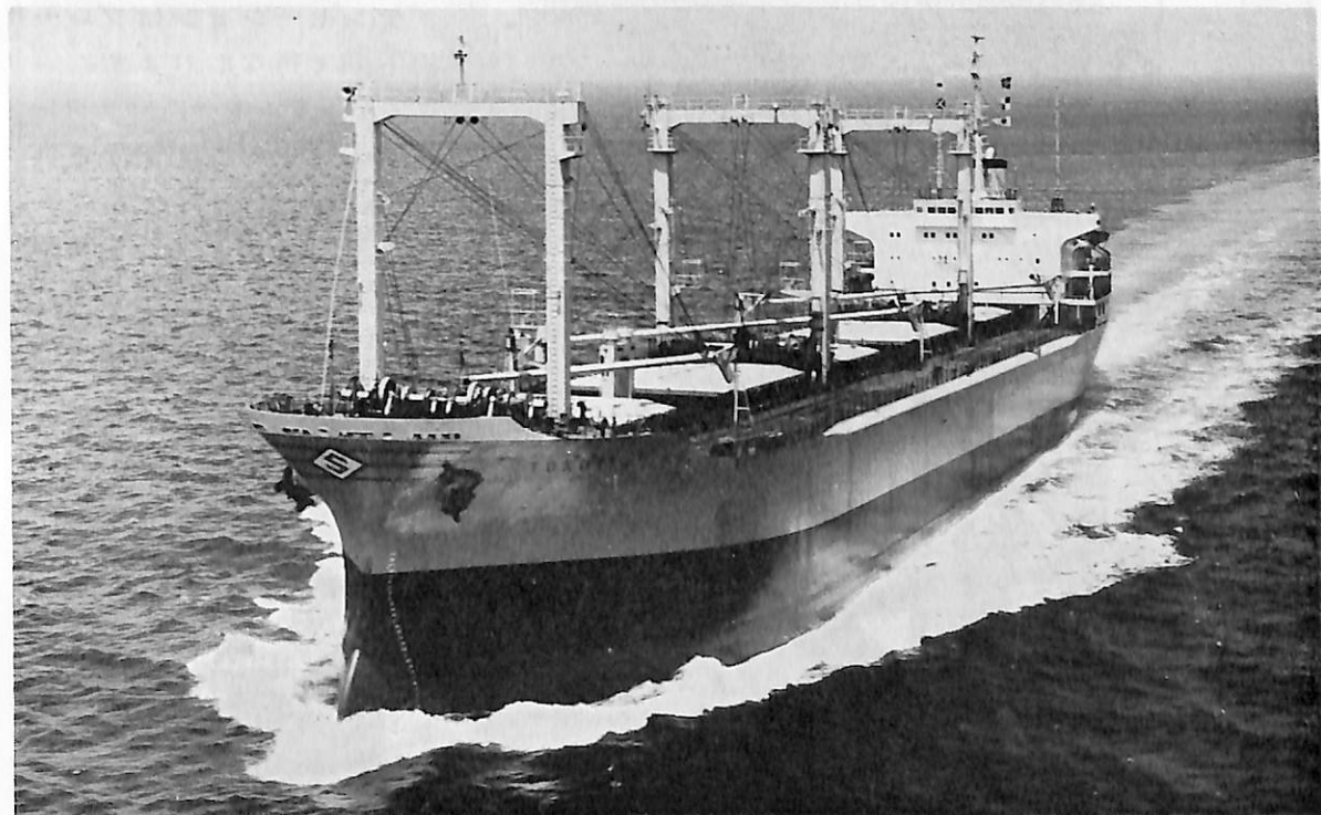
TOXOTIS (ばら積運搬船) 船主 Toxotis Compania Naviera S. A. (ギリシャ) 造船所 株式会社金指造船所 総噸数 19,166.34噸 純噸数 13,515噸 遠洋 船級 AB 載貨重量 33,122Lt 全長 182.18m 長(垂) 170.00m 幅(型) 27.00m 深(型) 15.20m 吃水 10.940m 満載排水量 40,571Lt 凹甲板船 主機 三井B&W6K74EF 型ディーゼル機関1基 出力 10,600PS×120RPM 燃料消費量 40.354t/d 航続距離 17,651海里 速力 15ノ ット 汽罐 サンロッドCPOB-15型 発電機 650PS×500KW×AC445V×3 貨物倉(ペール) 39,141.58m 3 (グレ ーン) 46,225.59m 3 清水倉 532m 3 燃料油倉 A 189m 3 C 2,080m 3 乗員 37名 工期 49-1-9, 49-5-6, 49-8-2
