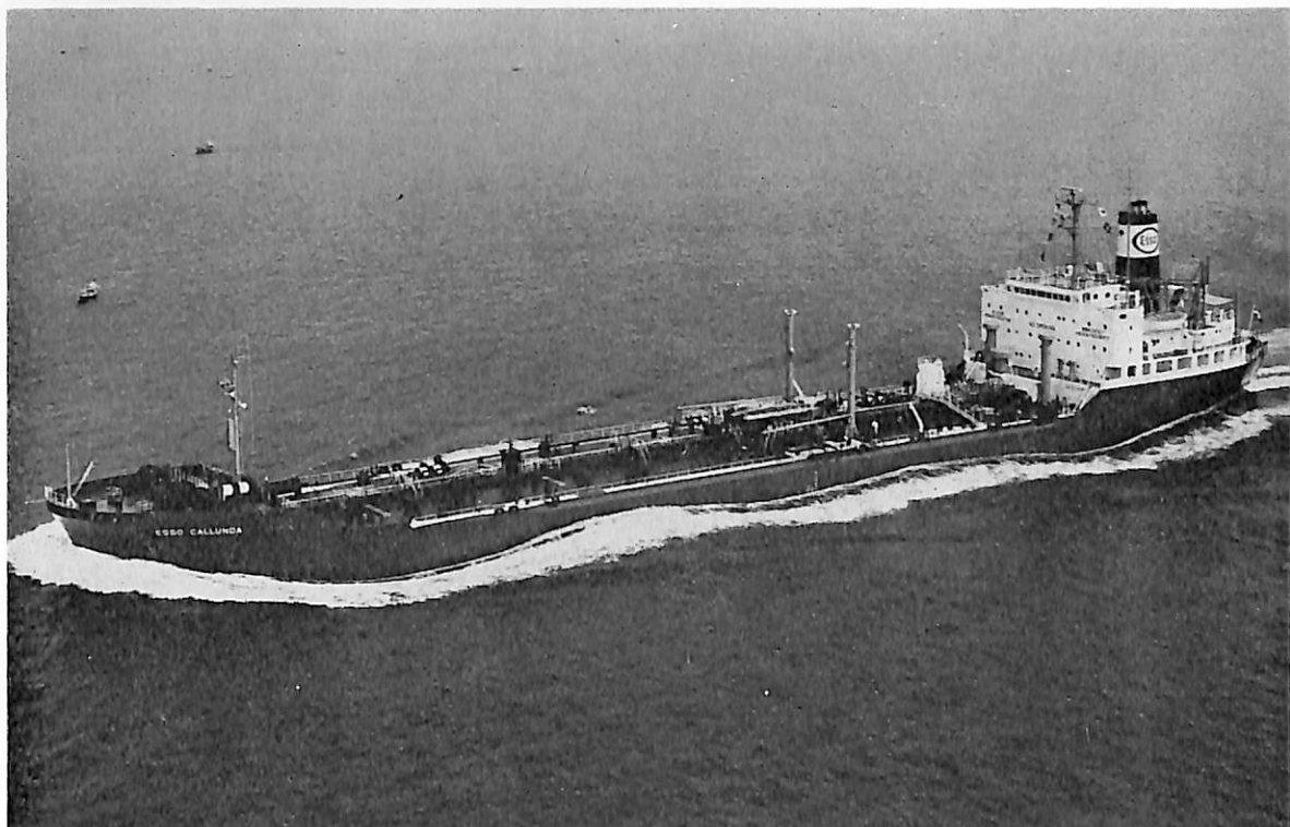
ESSO CALLUNDA (油槽船) 船主 Dansk Esso A. S. (リベリア) 造船所 日立造船・向島工場 総噸数 13,502.64噸 純噸数 7,859.69噸 遠洋 船級 AB 載貨重量 22,333噸 全長 161.20m 長(垂) 152.00m 幅(型) 23.50m 深(型) 12.75m 吃水 32' - 2 3/8" 満載排水量 28,463Lt 船首楼付一層甲板型 主機 日立B & W7K62EF型ディーゼル機関1基 出力 8,600PS×140RPM 燃料消費量 35.3t/d 速力 15.0ノット 汽罐 日 立造船型2胴水管ボイラー×1 発電機 687.5KVA, AC 450V 60Hz×3 貨油倉 930,517ft 3 清水倉 6,657ft 3 燃料油倉 66,893ft 3 乗員 36名 工期 49-2-9, 49-5-13, 49-8-9 設備 パウスラスター
