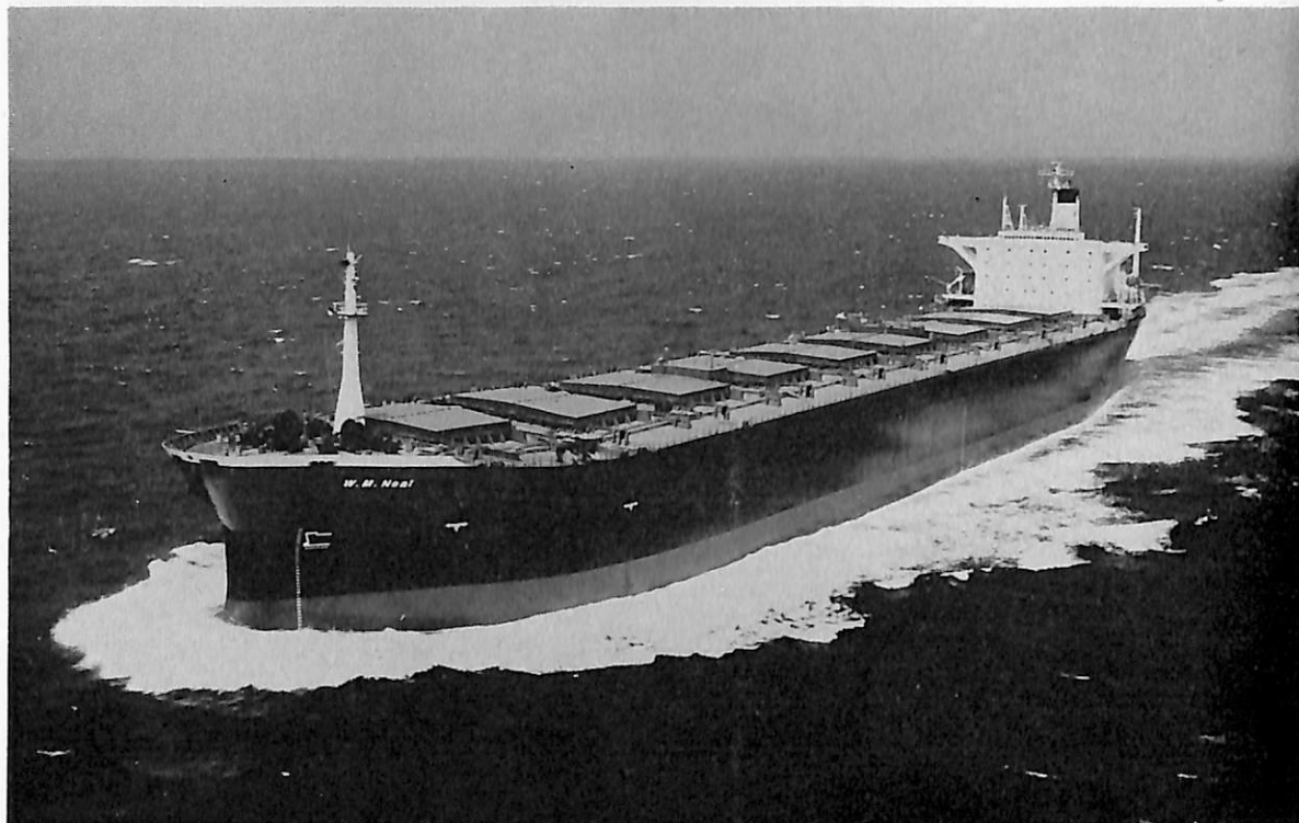
W.M. NEAL (ばら積貨物船) 船主 Canadian Pacific. (Bermuda) Ltd. 造船所 日本鋼管・鶴見造船所 総噸数 69,903.89噸 純噸数 44,473.05噸 遠洋 船級 LR 載貨重量 125,103噸 全長 260.00m 長(垂) 248.00 m 幅(型) 41.60m 深(型) 23.70m 吃水 16.808m 満載排水量 144,922噸 平型甲板船 主機三井 B&W 9 K84 EF型ディーゼル機関1基 出力 20,800PS×110RPM 燃料消費量 76.67kts 航続距離 23,300海里 速力 15.2 ノット 汽罐 AALBORG AQ3×1 10kg/cm 2 発電機 630KW×450V×2 640KW×AC450V×1 貨物倉(グレー ン) 143,647m 3 清水倉 341m 3 燃料油倉 5,256m 3 乗員 42名 工期 49-1-26, 49-5-10, 49-8-7
