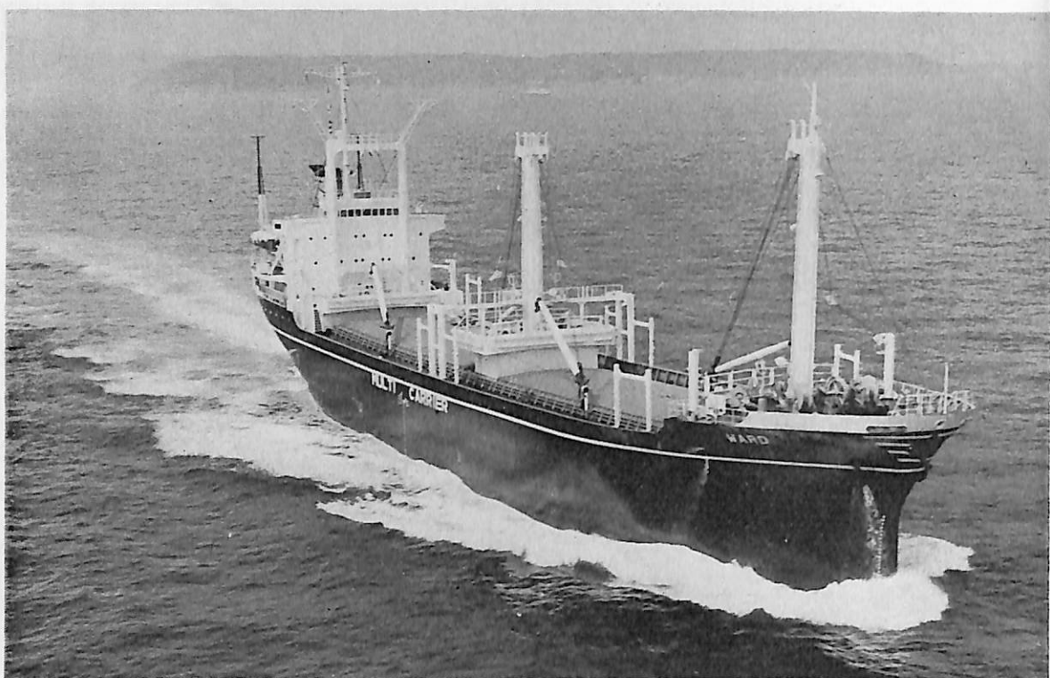
WARD (貨物船) 船主 Marfomentos Armadora. S. A. (リベリア) 造船所 下田船渠株式会社 総噸数 3,858.41噸 純噸数 2,537.84噸 遠洋 船級 NK 載貨重量 6,645噸 全長 106.65m 長(垂) 98.00m 幅(型) 17.00m 深(型) 8.50m 吃水 6.93m 凹甲板船 主機 赤阪鉄工6UET45/80D型ディーゼル機関1基 出力 3,825PS×218RPM 燃料消費量 155gr/psh 航続距離 8,307海里 速力 13ノット 汽罐 736kg/h 発電 機 220KVA×2 貨物倉(ベール) 8,212.59m 3 (グリーン) 8,688.67m 3 清水倉 549m 3 燃料油倉 565.77m 3 乗 員 30名 工期 48-12-11, 49-3-29, 49-7 設備 15Tデリック4本
