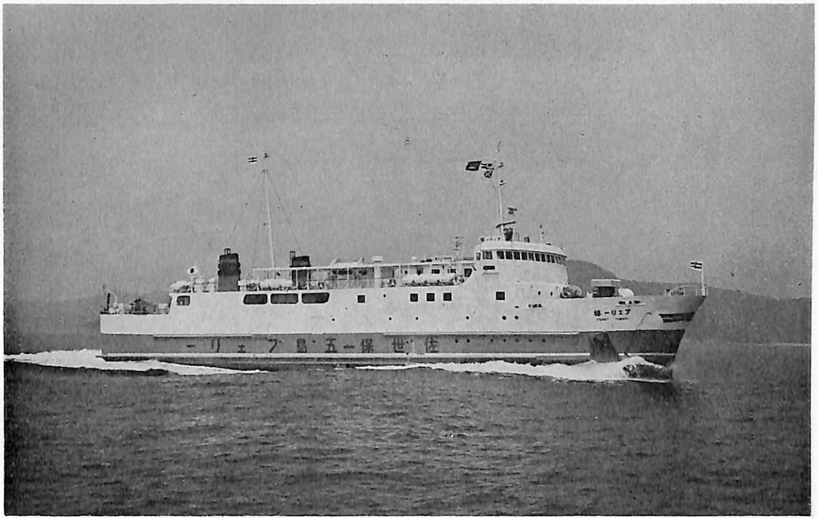
フェリー 樺 (旅客兼自動車航送船) 船主 船舶整備公団, 九州商船株式会社 造船所 内海造船・田熊工場 総噸数 1,150.89噸 純噸数 425.13噸 載貨重量 376.98噸 全長 68.62m 長(垂) 62.00m 幅(型) 13.00m 深(型) 4.60m 吃水 3.760m 満載排水量 1,656.0噸 全通船楼船 主機 阪神6LU38型ディーゼル機関1基 出力 1,785PS×298RPM 燃料消費量 15.0t/d 航続距離 1,444海里 速力 15.4ノット 汽罐 荏原製作所立形自然循環水管式 発電機 250KVA×2 車輛搭載数 8吨トラック6台 乗用車 20台 清水倉 33.26m 3 燃料油倉 67.00m 3 旅客 計 500名 乗員 35名 工期 49-1-11, 49-4-19, 49-7-30 設備 日立式アンチローリングタンク装備
