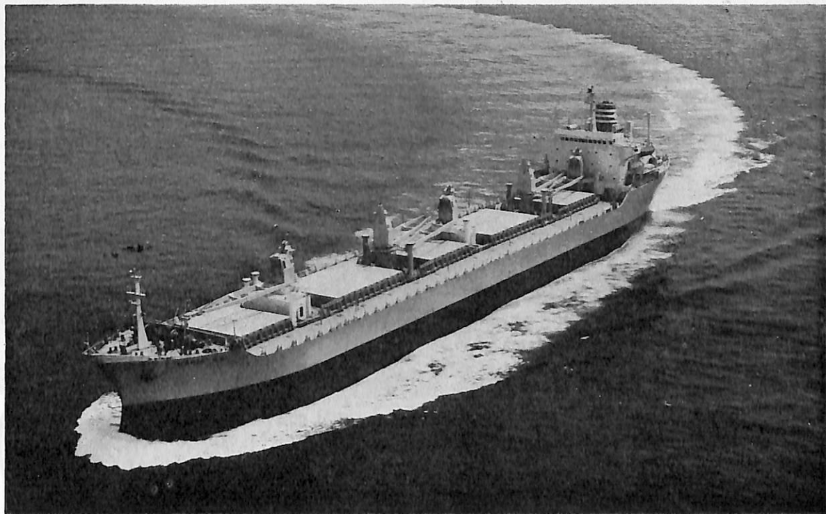
MARIA G.L. (ばら積貨物船) 船主 Elmona Inc. (ギリシャ) 造船所 株式会社村村造船所 総噸数 15,938.23噸 純噸数 11,158噸 遠洋 船級 AB 載貨重量 26,572Lt 全長 178.52m 長(垂) 167.00m 幅(型) 22.90m 深(型) 14.50m 吃水 10.403m 満載排水量 33,490噸 凹甲板型 主機 三菱スルザー7RND68型ディーゼル機関1基 出力 9,820PS×142RPM 燃料消費量 C 36.9t/d A 2.0t/d 航続距離 18,400海里 速力 15ノット 汽罐 スパナーボイラー 7kg/cm 2 , 1,200kg/h, 169.6°C×1 発電機 AC60Hz 500KVA(400kW)×450V×3 貨物倉(ベール) 32,595m 3 (グリーン) 36,841m 3 清水倉 F 126.9m 3 D 33.7m 3 燃料油倉 2,034.1m 3 乗員 36名 工期 49-2-14, 49-5-25, 49-9-10
