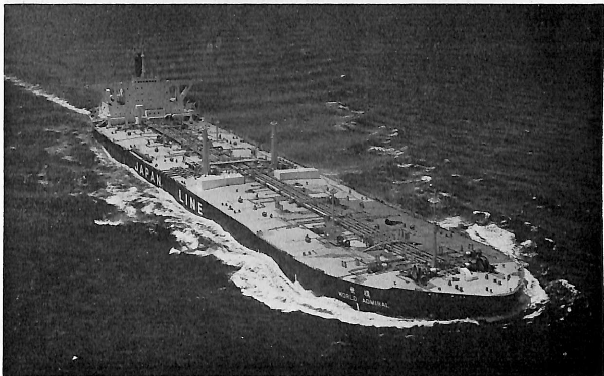
WORLD ADMIRAL (油槽船) 船主 Liberian Property Trausports Inc. (リベリア) 造船所 日立造船・堺工場 総噸数 106,673.30噸 純噸数 89,310.74噸 遠洋 船級 BV 載貨重量 237,312噸 全長 324.00m 長(垂) 310.00m 幅(型) 53.00m 深(型) 25.00m 吃水 19.458m 満載排水量 272,149噸 主機 日立UA360型タービン1基 出力 35,000PS×89RPM 燃料消費量 173.3t/d 航続距離 17,400海里 速力 15.7ノット 汽罐 日立BD72/55 UA型 72,000kg/h×2 発電機 1,520KW AC450V(タービン)×1 貨油倉 282,663.5m 3 清水倉 610.6m 3 燃料油倉 9,041.3m 3 乗員 43名 工期 48-11-14, 49-4-19, 49-8-20
