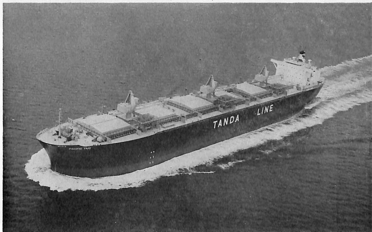
PACIFIC TAIO (貨物船) 船主 Pacific Lease Ltd.,Inc.(パナマ) 造船所 今治造船・丸亀工場 総噸数 48,296.02噸 純噸数 35,650.36噸 遠洋 船級 NK 載貨重量 57,173.04噸 全長 224.50m 長(垂) 213.00m 幅(型) 35.00m 深(型) 22.50m 吃水 11.528m 満載排水量 72,370噸 平甲板型 主機 三菱スルザ ー7RND76型ディーゼル機関1基 出力 12,600PS×118RPM 燃料消費量 47t/d 航続距離 15,500海里 速 力 14.70ノット 発電機 800KVA×3 貨物倉(クレーン) 116,883m 3 燃料油倉 2,646m 3 清水倉 503m 3 乗員 35名 工期 48-12-15, 49-6-16, 49-9-6
