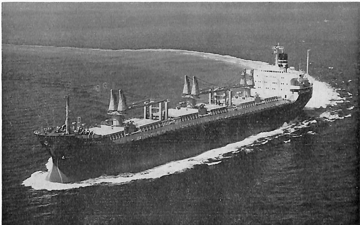
NORDPOL (ばら積貨物船) 船主 A/S Motortramp, D/S Orient A/S, D/S Norden A/S. (デンマーク) 造船所 三井造船・藤永田造船所 総噸数 19,631.42噸 純噸数 13,549.93噸 遠洋 船級 LR 載貨重量 34,258噸 全長 179.00m 長(垂) 170.00m 幅(型) 27.00m 深(型) 14.80m 吃水 10.96m 満載排水量 41,890噸 凹甲板船 主機 三井B&W6K74EF型ディーゼル機関1基 出力 10,600BHP×120RPM 燃料消費量 B 42.55t/d D 1.80t/d 航続距離 14,200海里 速力 15.0ノット 汽罐 水管壱型ボイラー 発電機 750BHP×3 貨物倉(ベール) 38,762m 3 (グリーン) 44,131m 3 清水倉 419.9m 3 燃料油倉 1,844.4m 3 乗員 34名 工期 49-4-2, 49-6-17, 49-9-5
