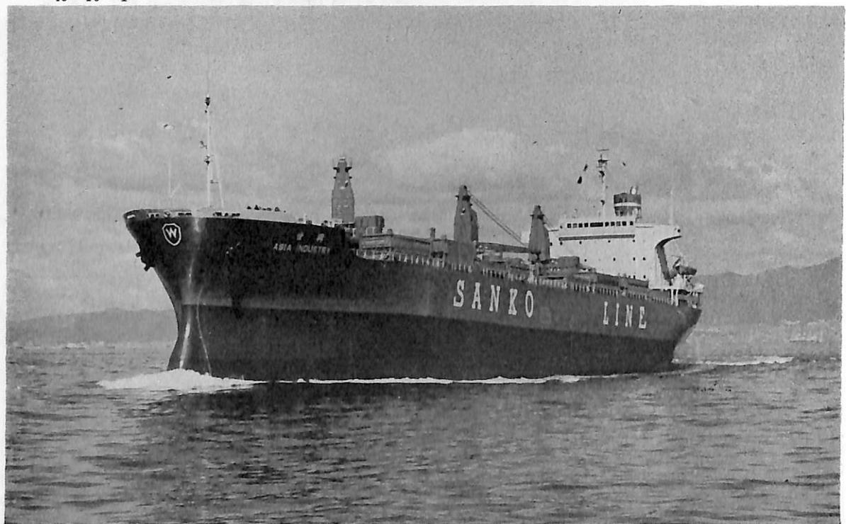
ASIA INDUSTRY (自動車兼ばら積貨物船) 船主 Liberian Raven Transports, Inc. (リベリア) 造船所 株式会社大阪造船所 総噸数 20,513.25噸 純噸数 14,481噸 遠洋 船級 AB 載貨重量 33,034噸 全長 185.371m 長(垂) 175.000m 幅(型) 26.000m 深(型) 16.100m 吃水 11.385m 満載排水量 42,732噸 船首楼付平甲板船 主機 IHIスルザー6RND76型ディーゼル機関1基 出力 10,800PS×117.8RPM 燃料消費量 43.25t/d 航続距離 15,600海里 速力 14.8ノット 汽罐 縦型横煙管式コクランコンポジットボイラー7kg/cm 2 ×1 発電機 A C 450V 500KVA×3 貨物倉(ベール) 40,088m 3 (グリーン) 41,396m 3 清水倉 465.4m 3 燃料油倉 2,137.9m 3 乗員 38名 工期 49-4-19, 49-7-10, 49-9-25
