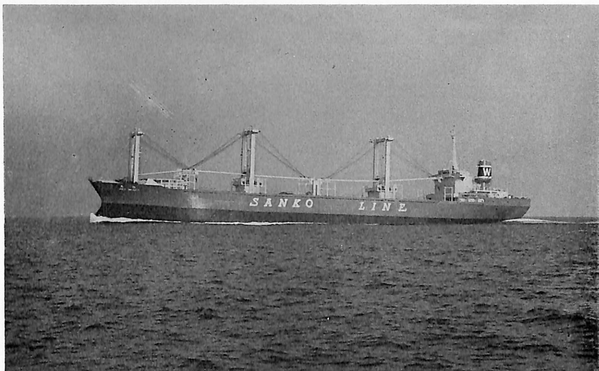
ASIA BEAUTY (貨物船) 船主 Liberian Belladonna Transports Inc. (リベリア) 造船所 株式会社神田造船所 総噸数 15,012.88噸 純噸数 10,848.87噸 遠洋 船級 NK 載貨重量 25,313.93噸 全長 175.84m 長(垂) 167.04m 幅(型) 25.45m 深(型) 13.70m 吃水 9.623m 満載排水量 32,541.82噸 凹甲板型 主機 IHI スルザー6RND68型ディーゼル機関1基 出力 8,910PS×144.8RPM 燃料消費量 35.6t/d 航続距離 15,300海里 速力 14.6ノット 汽罐 ガドリユウスサンロッドCPOB15 1基 発電機 445V×432KW×3 貨物倉(ベール) 31,907 m 3 (グレーン) 36,157 m 3 清水倉 377.44m 3 燃料油倉 1,868.85m 3 乗員 34名 工期 49-2-20, 49-6-21, 49-9-20
