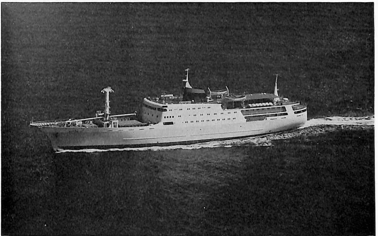
MAPINDUZI (貨客船) 船主 Halmashauri ya Uagiziaji Zana za Majenzi, Serikali ya Zanzibar (タンザニア) 造船所 新潟鉄工所・新潟造船工場 総噸数 3,999.43噸 純噸数 2,045.21噸 沿海 船級 LR 載貨重量 1,896.40 噸 全長 109.89m 長(垂) 97.00m 幅(型) 16.00m 深(型) 6.50m 吃水 4.716m 満載排水量 4,404.45噸 低 船首楼付全通船楼船 主機 新潟6MG40X型ディーゼル機関2基 出力 2 \times 2,550 PS \times 379 RPM 燃料消費量 24.5 t/d 航続距離 3,100海里 速力 15.5ノット 発電機 AC445V \times 900 KVA \times 2 AC445V \times 100 KVA \times 1 貨物倉(ベ ール) 4,417.00m 3 (グリーン) 4,858.12m 3 旅客 707名 清水倉 225.09m 3 燃料油倉 278.22m 3 乗員 55名 工期 48-9-21, 49-6-8, 49-9-14
