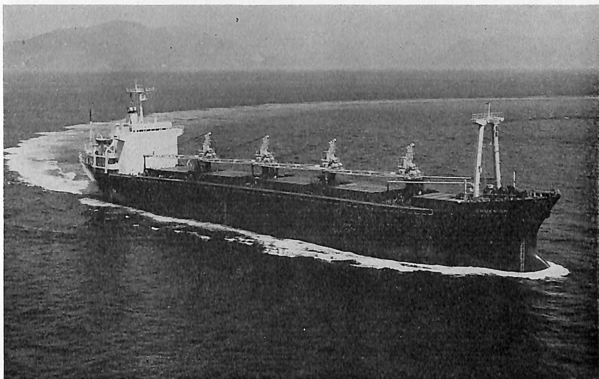
CHUEN ON (ばら積貨物船) 船主 Chuen On Shipping Company S.A. (パナマ) 造船所 日本鋼管・清水造船所 総噸数 12,692.33噸 純噸数 8,388噸 遠洋 船級 AB 載貨重量 22,070噸 全長 155.70m 長(垂) 145.70m 幅(型) 22.86m 深(型) 13.60m 吃水 9.909m 満載排水量 26,901噸 凹甲板型 主機 住友スルザー6RND 68型ディーゼル機関1基 出力 8,100PS×133RPM 燃料消費量 31.6t/d 速力 14.7ノット 汽罐 AALBORG コンボジット罐×1 発電機 AC450V310KW×2 貨物倉(ペール) 25,067.1m 3 (グリーン) 29,098.5m 3 清水倉 84.0m 3 燃料油倉 1,383m 3 乗員 37名, 外1名 工期 49-3-22, 49-6-7, 49-9-6
