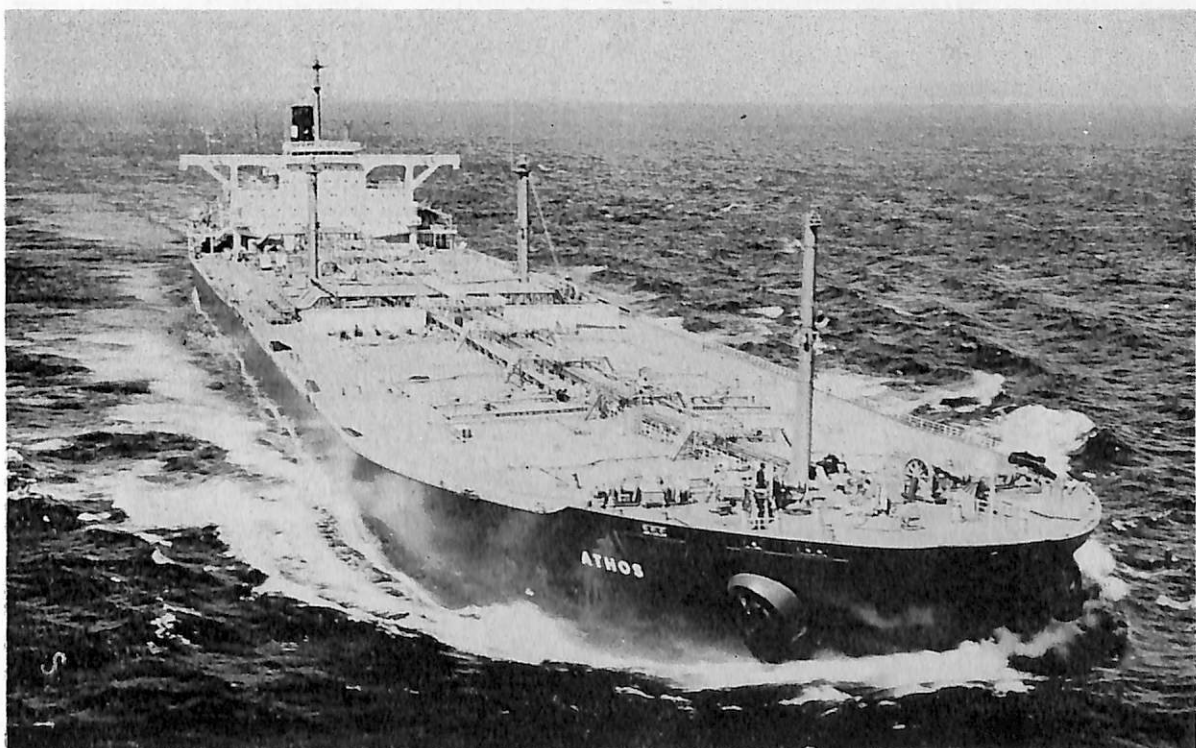
ATHOS (油槽船) 船主 Modil Oil Francaise (仏) 造船所 住友重機械工業・追浜造船所 総噸数 140,745噸 船級 BV 載貨重量 270,591Lt 長(垂) 324.00m 幅(型) 54.40m 深(型) 26.90m 吃水 20.96m 主機 住友スタルラバルAPタービン×1 出力 38,000PS×91RPM 工期 49-1-26, 49-5-17, 49-9-10
