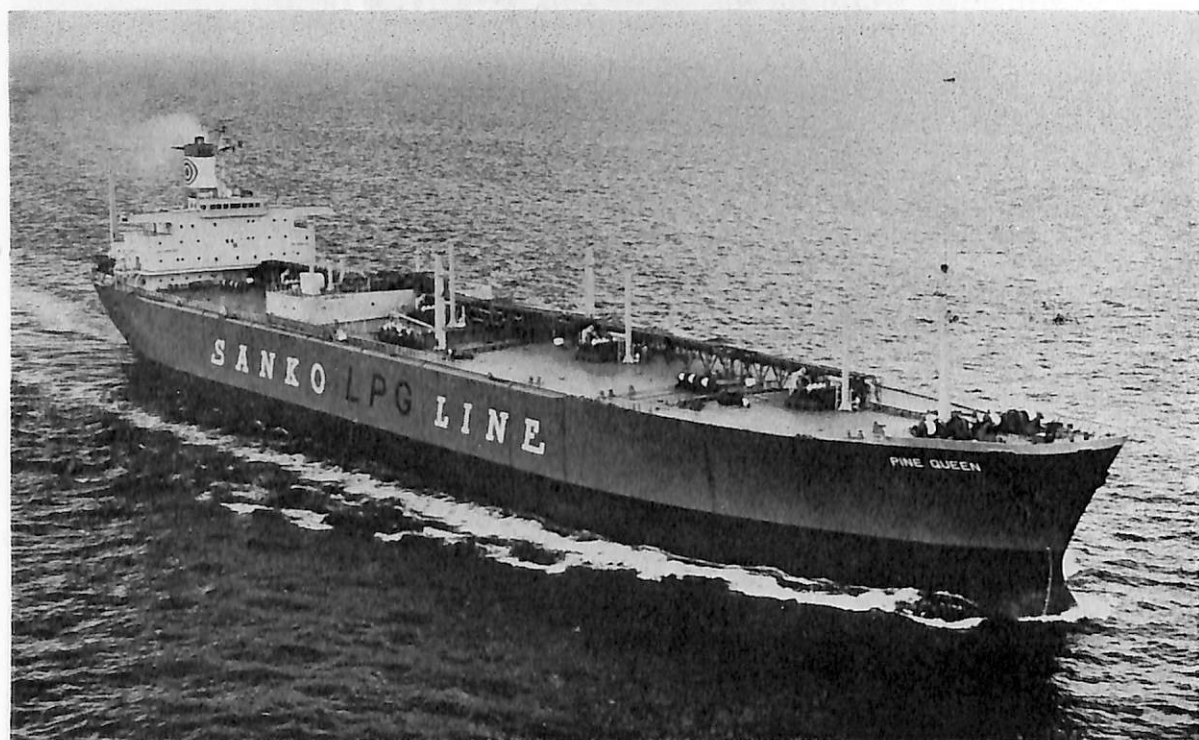
PINE QUEEN (LPG船) 船主 Pine Maritime Co. (リベリア) 造船所 三菱重工業・横浜造船所 総噸数 36,905噸 純噸数 24,955噸 遠洋 船級 NK 載貨重量 49,617噸 全長 223.96m 長(垂) 213.00m 幅(型) 34.60m 深(型) 21.40m 吃水 11.928m 満載排水量 68,157噸 平甲板船 主機 三菱スルザー6RND90型ディーゼル機関1基 出力 14,790PS×116RPM 燃料消費量 54.3t/d 航続距離 17,000海里 速力 15.65ノット 汽罐 強風通風油焚×1 排気エコノマイザ×1 発電機 450V×60Hz×700KW×3 貨油倉 70,139m 3 清水倉 574m 3 燃料油倉 3,255m 3 乗員 39名 工期 48-7-27, 49-2-22, 49-8-13
