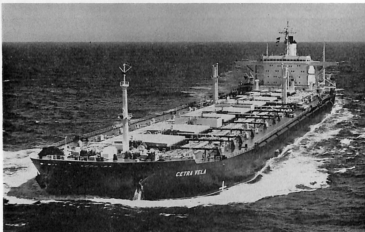
CETRA VELA (鉱石/油運搬船) 船主 Consortium Europeen De Trancports Maritimes (仏) 造船所 三菱重工業・横浜造船所 総噸数 92,910噸 純噸数 67,556噸 遠洋 船級 BV 載貨重量 169,317噸 全長 294.85 m 長(垂) 280.00m 幅(型) 47.40m 深(型) 24.10m 吃水 17.922m 満載排水量 199,618噸 平甲板船 主機 三菱スルザー10RND90型ディーゼル機関1基 出力 26,100PS×118RPM 燃料消費量 94.4t/d 速力 15.3ノット 航続距離 27,000海里 汽罐 AC 450V×60Hz×850KW×3 発電機 三菱CE2DRUM, WT×2 貨物倉(グリーン) 89,804 m 3 貨油倉 198,906 m 3 清水倉 581 m 3 燃料油倉 8,033 m 3 乗員 39名 工期 48-12-21, 49-5-20, 49-8-14
