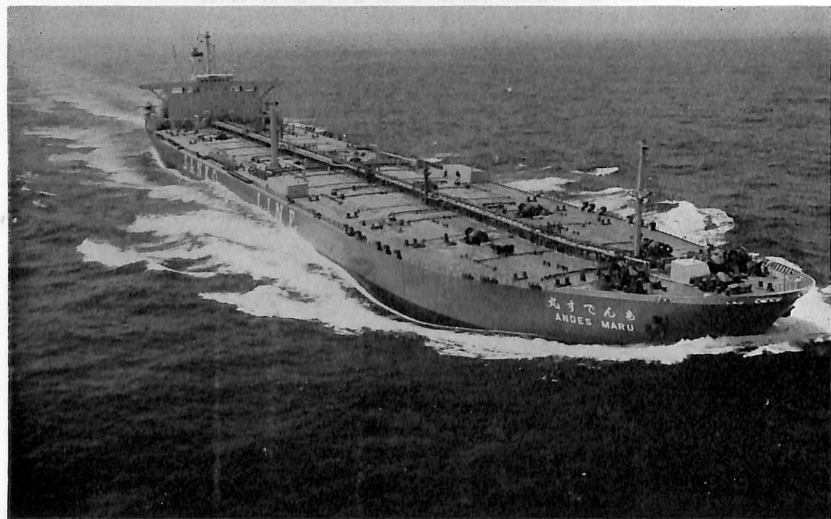
あ ん で す 丸 (油槽船) 船主 三光汽船株式会社 造船所 石川島播磨重工業・知多工場 総噸数 135,556.51噸 純噸数 99,639.95噸 遠洋 船級 NK 載貨重量 273,150噸 全長 337.58m 長(垂) 320.00 m 幅(型) 54.50m 深(型) 27.00m 吃水 21.033m 平甲板船 主機 IHI クロスコンパウンド,デュアルタンデム型 タービン1基 出力 36,000PS×80RPM 燃料消費量 175.39t/d 航続距離 17,500海里 速力 16.0ノット 汽罐 IHI-MDM型×2, 61.2kg/cm 2 G×515°C×77t/h 発電機 1,600KW×60Hz×450V×1, 800KW×60Hz×450V×2 貨油倉 319,938.5m 3 清水倉 1,052.6m 3 燃料油倉 9,074.8m 3 乗員 36名, 外7名 工期 48-6-19, 49-1-25, 49-6-25 知多工場建造第1船
