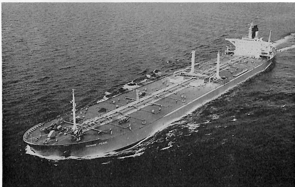
HONAM PEARL (油槽船) 船主 Trinitall Tanker, Inc. (リベリア) 造船所 日立造船・因島工場 総噸数 83,814.55噸 純噸数 66,115噸 遠洋 船級 AB 載貨重量 186,508噸 全長 315.00m 長(垂) 302.15m 幅(型) 44.20m 深(型) 24.50m 吃水 18.97m 満載排水量 216,556噸 平甲板型 主機 日立B & W 12K84EF 型ディーゼル機関1基 出力 28,100PS×110RPM 燃料消費量 103.2t/d 航続距離 16,700海里 速力 15.5ノ ット 汽罐 80,000kg/h×15.5kg/cm 2 発電機 1,000KW, AC450V 1,800rpm×1, 750KW, AC 450V×600rpm×2 貨油倉 225,352.82m 3 清水倉 542.60m 3 燃料油倉 5,095.80m 3 乗員 42名 工期 49-2-9, 49-6-25, 49 -10-3
