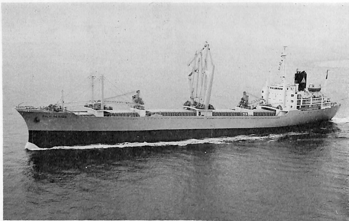
PALM ISLANDS (貨物船) 船主 Bule Sea Shipping Co., Ltd. (ソマリア) 造船所 林兼造船・長崎造船所 総噸数 9,650.17噸 純噸数 6,158.58噸 遠洋 船級 NK 載貨重量 13,407.12噸 全長 155.60m 長(垂) 145.00m 幅(型) 21.20m 深(型) 12.20m 吃水 9.404m 満載排水量 19,059.00噸 凹甲板船 主機 川重MAN・K6 Z70/ 120 E型ディーゼル機関1基 出力 8,370PS×135.2RPM 燃料消費量 31.8t/d 航続距離 13,700海里 速力 16.80ノット 汽罐 コクラン罐 7 kg/cm 2 ×1台 発電機 720KVA×2台 貨物倉(ペール) 18,516.45m 3 (グレーン) 20,318.36m 3 清水倉 714.81m 3 燃料油倉 1,539.95m 3 乗員 38名 工期 49-6-7, 49-7-5, 49-10-31
