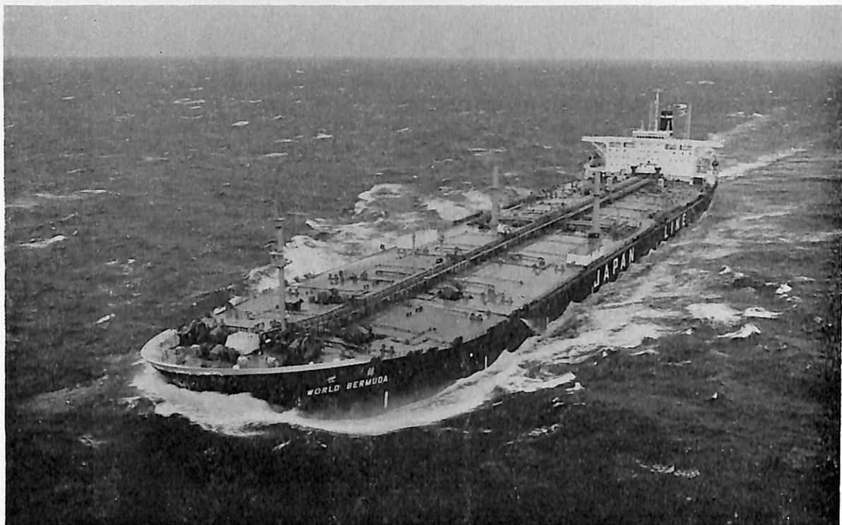
WORLD BERMUDA (世錦)(油槽船) 船主 Liberian Ulysses Transports, Inc. (リベリア) 造船所 石川島播磨重工業・知多工場 総噸数 117,775.23噸 純噸数 97,320噸 遠洋 船級 AB 載貨重量 275,938噸 全長 337.058 m 長(垂) 320.00m 幅(型) 54.50m 深(型) 27.00m 吃水 20.756m 平甲板型 主機 IHI-クロスコンバウントデュアルタンデムタービン1基 出力 36,000PS×80RPM 燃料消費量 175.39t/d 航続距離 17,500海里 速力 16.0ノット 汽罐 IHI-MDM型×1 61.2kg/cm 2 G×77t/h 発電機 1,600KW×60Hz×1 800KW×60Hz×2 貨油倉 319,938.5m 3 清水倉 1,052.6m 3 乗員 28名, 外17名 工期 48-12-7, 49-9-29, 49-10-9
