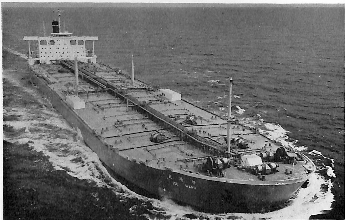
伊 勢 丸 (油槽船) 船主 照国海運株式会社 造船所 石川島播磨重工業・呉工場 総噸数 134,677.76噸 純噸数 99,754.82噸 遠洋 船級 NK 載貨重量 258,695噸 全長 337.00m 長(垂)320.00 m 幅(型) 54.50m 深(型) 27.00m 吃水 20.031m 平甲板船 主機 IHI 船用タービン1基 出力 36,000PS× 80RPM 燃料消費量 173.8t/d 航続距離 15,670海里 速力 16.07ノット 汽罐 IHI-FW,MDM×2, 61.2kg/cm 2 G×515°C×77t/h 発電機 1,600KW×60Hz×450V×1, 800KW×60Hz×450V×2 貨油倉 319,954.08m 3 清水倉 1,050.34m 3 燃料油倉 8,694.09m 3 乗員 31名, 外9名 工期 49-1-23, 49-6-7, 49-10-29
