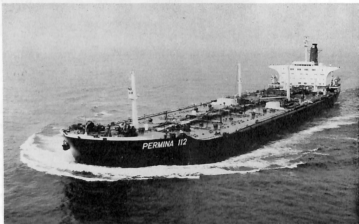
PERMINA 112 (油槽船) 船主 Agdesidens Rederi A/S. (ノルウェー) 造船所 住友重機械工業・浦賀造船所 総噸数 77,409.60噸 純噸数 54,038.13噸 遠洋 船級 NV 載貨重量 138,555噸 全長 267.00m 長(垂) 258.00m 幅(型) 44.00m 深(型) 22.90m 吃水 17.002m 満載排水量 164,491噸 船首楼付一層甲板型 主機 住友スル サー9RND90型ディーゼル機関1基 出力 22,200PS×116RPM 燃料消費量 93.1t/d 航続距離 27,000海里 速力15.06ノット 汽罐 二胴水管式 35t/h 2台 排ガスエコマイザー 2.5t/h 1台 発電機 750KW 3台 貨油倉 171,521m 3 清水倉 332.6m 3 燃料油倉 7,491.6m 3 乗員 42名 工期 48-12-12, 49-6-17, 49-10-15
