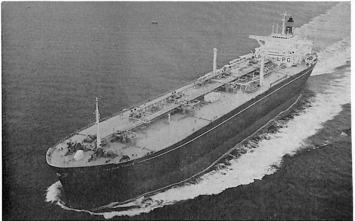
PALACE TOKYO (LPG船) 船主 Palace Shipping Co., Ltd. (日本) 造船所 日立造船・因島工場 総噸数 64,378.85噸 純噸数 41,295.26噸 遠洋 船級 NK 載貨重量 65,454噸 全長 246.128m 長(垂) 234.00 m 幅(型) 39.90m 深(型) 25.00m 吃水 12.70m 満載排水量 93,216噸 一層甲板船 主機 日立B & W 9K84 EF型ディーゼル機関1基 出力 21,100PS×110RPM 燃料消費量 77.5t/d 航続距離 18,796海里 速力 16.4 ノット 汽罐 12,500kg/h × 9kg/cm 2 × 1 発電機 860KW, AC450V, 60Hz × 4 LPGタンク 100,181.304m 3 清水倉 444.26m 3 燃料油倉 4,221.44m 3 乗員 34名 工期 48-12-10, 49-6-5, 49-10-18
