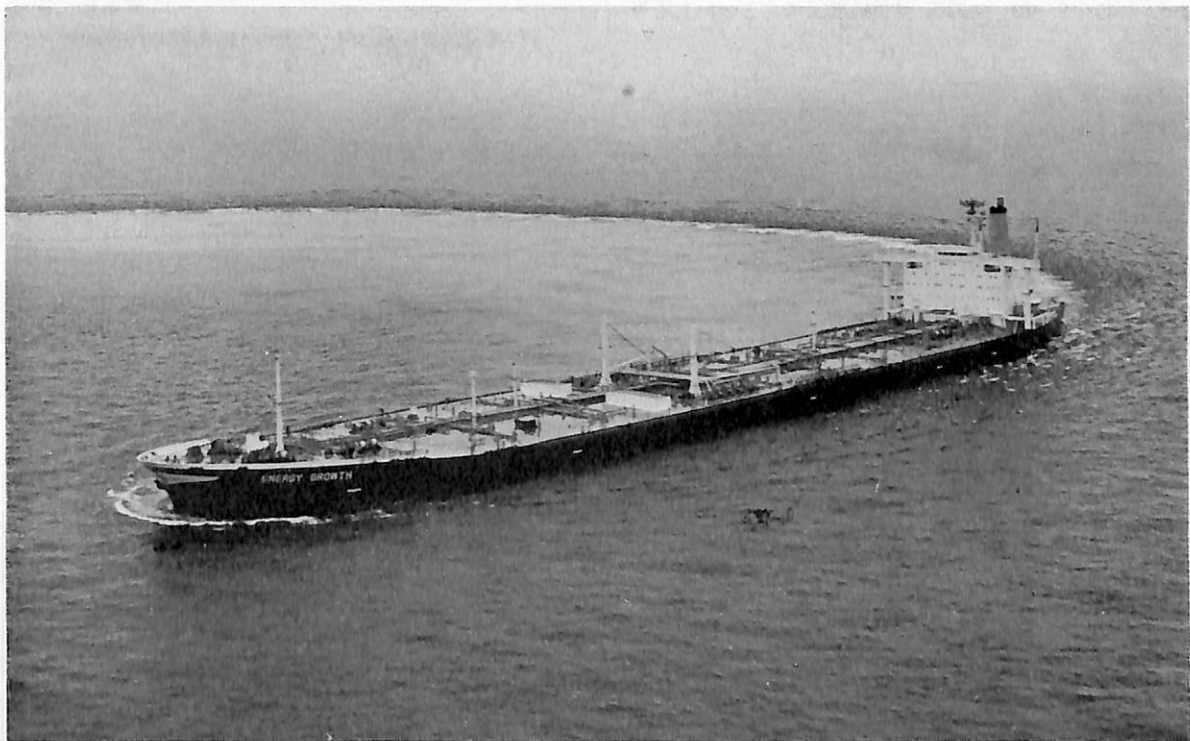
ENERGY GROWTH (油槽船) 船主 Transworld Tankers Transport Inc. (リベリア) 造船所 川崎重工業・ 坂出工場 総噸数 105,662.52噸 純噸数 88,025.08噸 遠洋 船級 NK 載貨重量 230,265Lt 全長 319.93m 長 (垂) 305.00m 幅(型) 53.00m 深(型) 25.30m 吃水 19.653m 満載排水量 263,758Lt 平甲板型 主機 川崎 UA 360型 2段減速歯車装置付船用タービン1基 出力 35,000PS×89RPM 燃料消費量 174.3t/d 航続距離 16,670海里 速力 16.14ノット 汽罐 川崎UMG 72/56 UA型 2胴水管式×2基 発電機 1,600KW×2, 000KVA× AC 450V 1基 750KW×937.5KVA×AC 450V 2基 貨油倉 287,860.43m 3 燃料油倉 8,315.96m 3 清水倉 594.49 m 3 乗員 49名 工期 48-12-25, 49-6-11, 49-10-8
