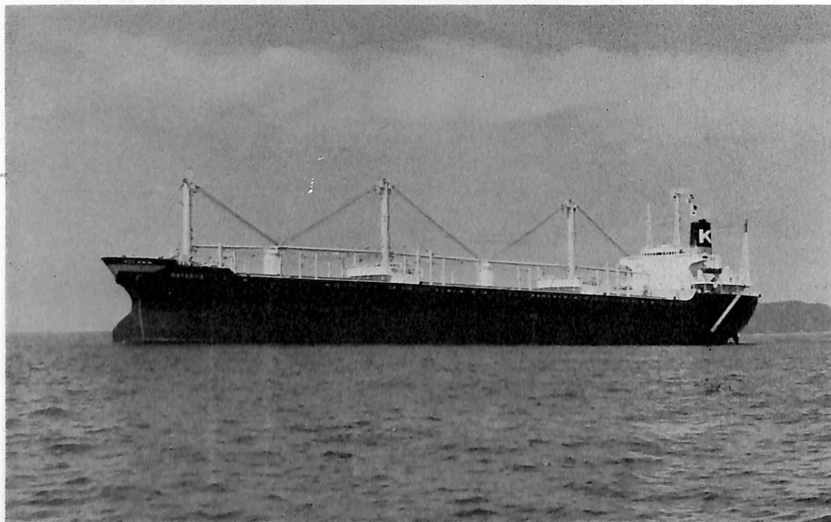
NATASHA (ばら積貨物船) 船主 Grand Harmony Inc. (リベリア) 造船所 今治造船株式会社 総噸数 15,855.46噸 純噸数 9,840.82噸 遠洋 船級 BV 載貨重量 29,622.40噸 全長 175.17m 長(垂) 165.00m 幅(型) 26.00m 深(型) 14.50m 吃水 10.323m 満載排水量 37,146.6噸 ウェル甲板型 主機 三菱スルザー7 RND68型ディーゼル機関1基 出力 10,395PS×145RPM 燃料消費量 37.8t/d 航続距離 17,100海里 速力 14.50ノット 汽罐 コ克蘭コンポジット 7.0kg/cm 2 1,200kg/h(排ガス) 発電機 AC450V 600KVA×2 貨物倉(ベール) 35,237.18m 3 (グリーン) 36,509.42m 3 燃料油倉 2,316.03m 3 清水倉 393.03m 3 乗員 36名 工期 49-2-23, 49-7-3, 49-9-27
