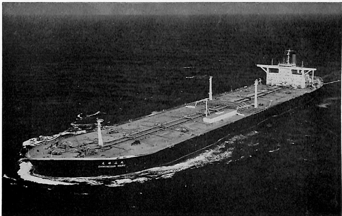
大 峰 山 丸 (油槽船) 船主 大阪商船三井船舶株式会社 造船所 三井造船・千葉造船所 総噸数 124,027.32噸 純噸数 88,214.83噸 遠洋 船級 NK(MO) 載貨重量 234,160噸 全長 324.00m 長(垂) 310.00m 幅(型) 54.00m 深(型) 26.40m 吃水 19.531m 満載排水量 269,221噸 平甲板型 主機 三井B&W 10K98FF型ディーゼル機関1基 出力 32,300PS×97.5RPM 燃料消費量 130t/d 航続距離 12,700海里 速 力 15.80ノット 汽罐 三井2胴式モノウォール型水管1基 発電機 1,000KW×1 760KW×2 貨油倉 286,837.0m 3 清水倉 655.2m 3 燃料油倉 5,691.4m 3 乗員 29名 工期 49-1-22, 49-6-22, 49-10-8
