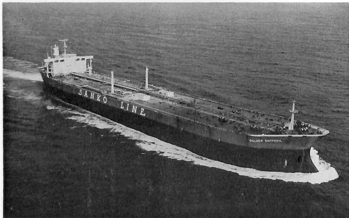
GOLDEN DAFFODIL (油槽船) 船主 Liberian Daffodil Shipping Inc. (リベリア) 造船所 石川島播磨重工業・ 横浜工場 総噸数 117,038.07噸 純噸数 85,368.44噸 遠洋 船級 NK 載貨重量 232,276噸 全長 317.00m 長 (垂) 300.00m 幅(型) 50.00m 深(型) 27.00m 吃水 20.733m 平甲板船 主機 IHI-クросコンパウンド型タ ービン1基 出力 33,000PS×80RPM 燃料消費量 160t/d 航続距離 18,615海里 速力 16.0ノット 汽罐 MD M×2, 61.2kg/cm 2 G×515°C 発電機 1,400KW×60Hz×1, 720KW×60Hz×2 貨油倉 278,883.64m 3 清水倉 663.19m 3 燃料油倉 8,509.15m 3 乗員 44名 工期 49-2-8, 49-6-26, 49-10-9
