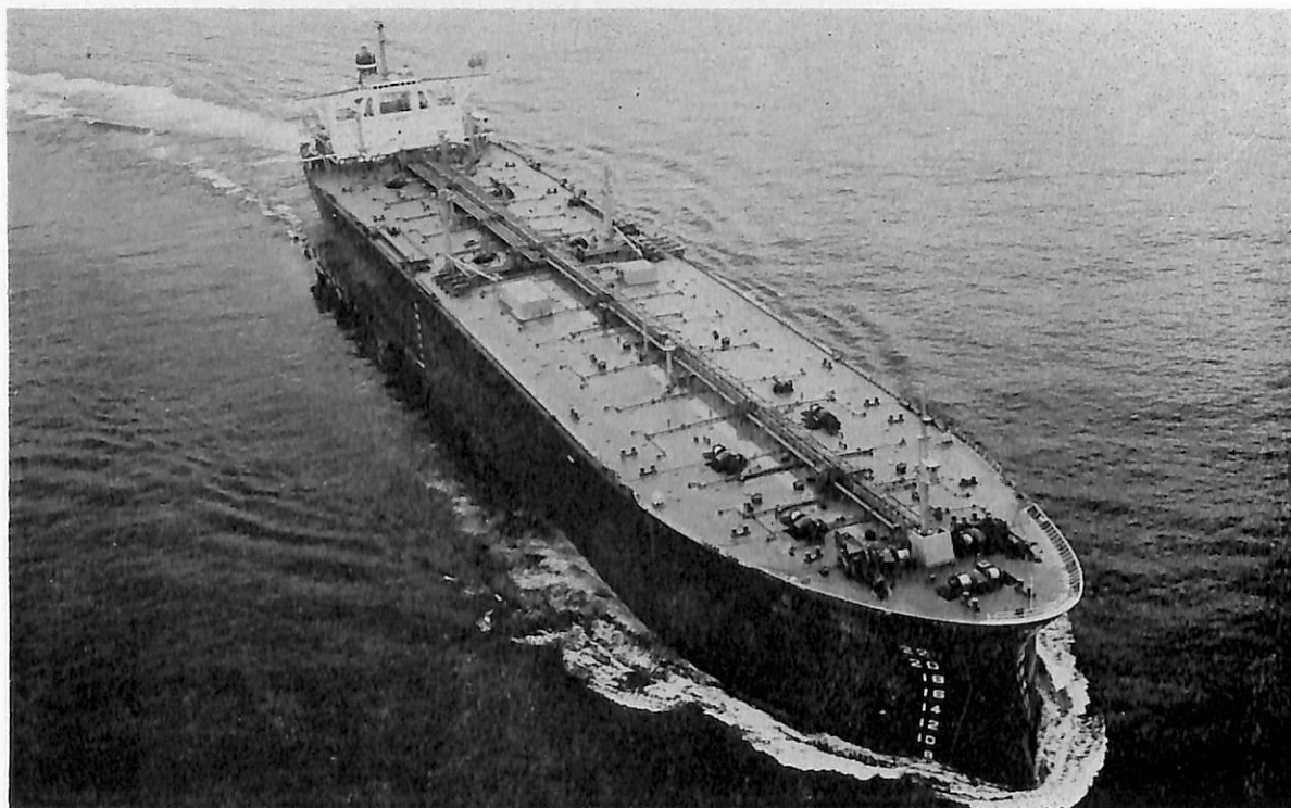
WORLD DIPLOMAT (油槽船) 船主 Liberian Acacia Transports, Inc. (リベリア) 造船所 石川島播磨重工業・横浜工場 総噸数 104,033.08噸 純噸数 85,336噸 遠洋 船級 AB 載貨重量 234,426噸 全長 317.00 m 長(垂) 300.00m 幅(型) 50.00m 深(型) 27.00m 吃水 20.759m 主機 IHI-タービン1基 出力 33,000PS×80RPM 燃料消費量 166t/d 航続距離 15,800海里 速力 16.0ノット 汽罐 61.2kg/G×72t/h 貨油倉 278,883.42m 3 清水倉 441.89m 3 燃料油倉 9,058.56m 3 乗員 34名, 外10名 工期 48-12-6, 49-4-17, 49-7-30
