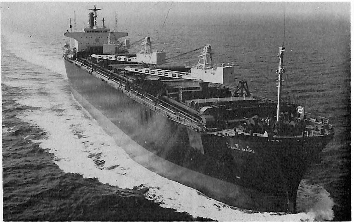
大 豊 丸 (木材チップ運搬船) 船主 新和海運株式会社 造船所 住友重機械工業・浦賀造船所 総噸数 31,973.97噸 純噸数 23,304.53噸 遠洋 船級 NK 載貨重量 37,176噸 全長 196.00m 長(垂) 188.00m 幅(型) 29.40m 深(型) 20.80m 吃水 10.804m 満載排水量 47,023噸 全通一層甲板型 主機 住友スルザー 6RND76型ディーゼル機関1基 出力 10,200PS×116RPM 燃料消費量 40.5t/d 航続距離 15,000海里 速力 15.25ノット 汽罐 重油専焼立円筒型 1.2t/h×1基 排気ガスエコマイザー 1.2t/h×1基 発電機 AC450V×620 KW×3台 貨物倉(グリーン) 76,566m 3 清水倉 380.4m 3 燃料油倉 1,987.8m 3 乗員 30名 工期 49-3-28, 49- 7-30, 49-10-29
