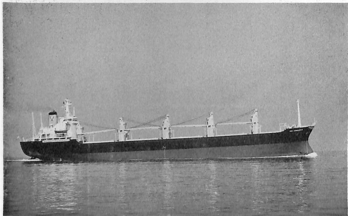
VAN CONQUEROR (ばら積貨物船) 船主 Eastern Navigation Co., Inc. (リベリア) 造船所 林兼造船・下 関造船所 総噸数 15,940.69噸 純噸数 10,690.69噸 遠洋 船級 BV 載貨重量 27,562Lt 全長 176.95m 長 (垂) 165.00m 幅(型) 25.00m 深(型) 14.20m 吃水 10.25m 満載排水量 35,570噸 凹甲板船 主機 三菱重 工2サイクル単動クロスベツト7RND68型ディーゼル機関1基 出力 10,400PS×140RPM 燃料消費量 35t/d 航続距離 14,500海里 速力 14.75ノット 汽罐 縦コクラン7kg/cm 2 G×1,500kg/h 発電機 500KVA×450V×3 貨物倉(ベール) 35,249m 3 (グリーン) 36,172m 3 清水倉 405m 3 燃料油倉 1,964m 3 乗員 43名 工期 49-4- 19, 49-7-5, 49-10-11
