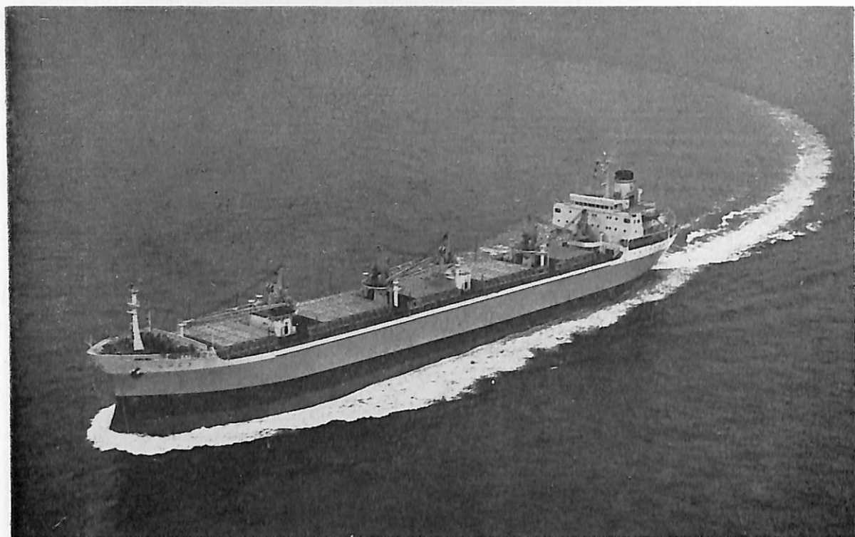
LUCY (ばら積貨物船) 船主 Cape Palmas Shipping Company (ギリシャ) 造船所 株式会社名村造船所 総噸数 16,005.92噸 純噸数 10,782噸 遠洋 船級 AB 載貨重量 26,631噸 全長 177.03m 長(垂) 167.00m 幅(型) 22.90m 深(型) 14.50m 吃水 10.407m 満載排水量 33,486噸 凹甲板型 主機 三菱スルザー6RND76 型ディーゼル機関1基 出力 10,200PS×116RPM 燃料消費量 C 38.3 A 2.0t/d 航続距離 18,100海里 速力 15.1ノット 汽罐 フレミングボイラー7kg/cm 2 ×169.6°C 1,350kg/h 発電機 AC60Hz, 500KVA(400KW), 450V ×3 貨物倉(ベール) 32,890m 3 (グリーン) 34,247m 3 清水倉 156.2m 3 燃料油倉 2,036.4m 3 乗員 36名 工期 49-3-29, 49-7-9, 49-10-15
