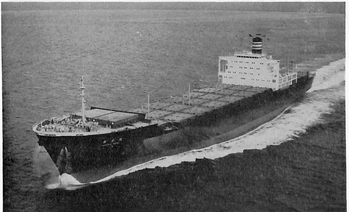
博多丸 (コンテナ船) 船主 日本郵船株式会社 造船所 三菱重工業・神戸造船所 総噸数 30,922.40噸 純噸数 17,727.33噸 遠洋 船級 NK(MO) 載貨重量 27,203噸 全長 218.41m 長(垂) 204.00m 幅(型) 31.60m 深(型) 18.90m 吃水 11.20m 満載排水量 44,474噸 主機 三菱12UEC85/180 D型 ディーゼル機関1基 出力 30,600PS×112RPM 燃料消費量 112t/d 航続距離 13,500海里 速力 22.1ノット 汽罐 乾燃室付 2,810kg/h 発電機 770KW, AC450V, 60Hz × 4 コンテナ積載数 20' 換算 1,409箇 清水倉 451.6m 3 燃料油倉 4,865.2m 3 乗員 32名, 外12名 工期 49-1-10, 49-6-20, 49-9-20
