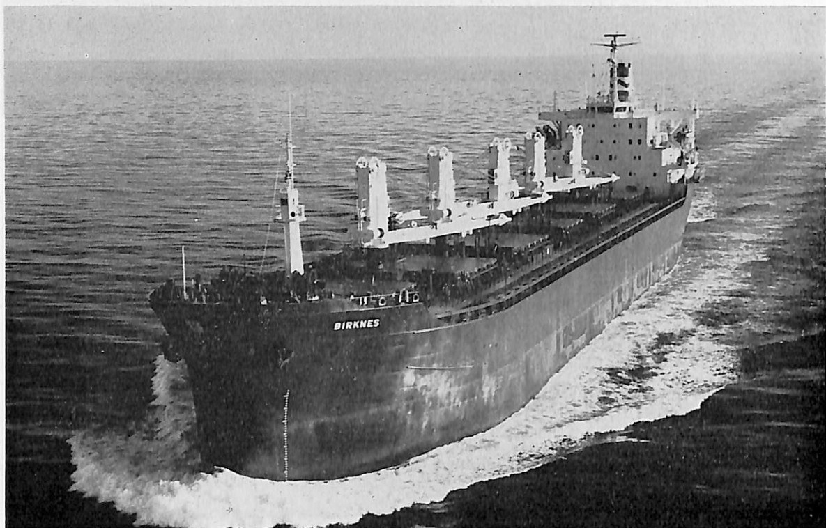
BIRKNES (ばら積貨物船) 船主 A/S Kristian Jebsens Rederi. (ノルウェー) 造船所 日本鋼管・清水造船所 総噸数 20,167.61噸 純噸数 12,420.32噸 遠洋 船級 LR 載貨重量 35,224噸 全長 177.00m 長(垂) 167.30m 幅(型) 27.80m 深(型) 15.06m 吃水 11.153m 満載排水量 43,332噸 凹甲板型 主機 住友スルザー7RND76 型ディーゼル機関1基 出力 12,600PS×118RPM 燃料消費量 48.1t/d 航続距離 18,300海里 速力 15.0ノ ット 汽罐 豎型水管式×1 発電機 AC4500,480KW×600rpm×3 貨物倉(ベール) 38,773.5m 3 (グレーン) 40,389.00m 3 清水倉 206.00m 3 燃料油倉 2,628.0m 3 乗員 32名 工期 49-6-10, 49-9-9, 49-11-26
