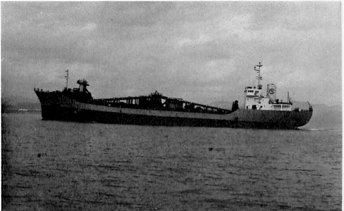
いーぐる (セメント運搬船) 船主 中央信託銀行 造船所 鹿児島ドック鉄工株式会社 総噸数 4,176.45噸 純噸数 2,531.16噸 沿海 載貨重量 6,859.8噸 全長 114.90m 長(垂) 105.50m 幅(型) 16.10m 深(型) 8.10m 吃水 6.916m 満載排水量 8,995.0噸 凹甲板船 主機 ダイハツ6DSM-32型ディーゼル機関2基 出力 2×3,570PS×209RPM 燃料消費量 165g/ps/h 速力 13.1ノット 汽罐 クレイトンWHO-50型 発電機 200KVA×3 貨物倉(グリーン) 5,881.0m 3 清水倉 102.27m 3 燃料油倉 252.72m 3 工期 49-6-24, 49-9-19, 49-11-30
