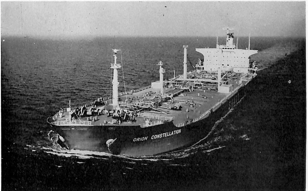
ORION CONSTELLATION (油槽船) 船主 Mitsubishi Corporation 造船所 三菱重工業・広島造船所 総噸数 60,491.24噸 純噸数 45,718.98噸 遠洋 船級 LR 載貨重量 123,965噸 全長 259.1m 長(垂) 247.0m 幅(型) 40.6m 深(型) 22.3m 吃水 16.836m 満載排水量 143,549噸 船首楼付平甲板船 主機 三菱スルザー-9 RND90型ディーゼル機関×1 出力 23,490PS×118RPM 燃料消費量 86.3t/d 航続距離 25,700海里 速力 15.6ノット 汽罐 三菱CE型×1 発電機 AC450V×937.5KVA×3 貨油倉 147,755.3m 3 清水倉 515.8m 3 燃料 油倉 7,002.3m 3 乗員 37名 工期 49-3-29, 49-8-7, 49-10-31
