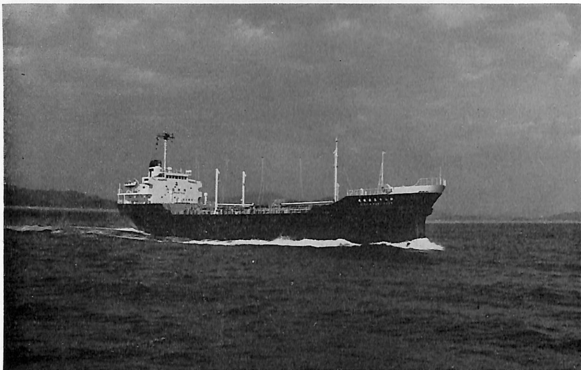
第二十五永進丸(油槽船) 船主 興栄海運株式会社 造船所 高知重工株式会社 総噸数 2,814.96噸 純噸数 1,534.83噸 沿海 船級 NK 載貨重量 5,478.35噸 全長 95.58m 長(垂) 88.08m 幅(型) 15.00m 深(型) 8.00m 吃水 7.002m 満載排水量 7,118噸 凹甲板船 主機 赤阪鉄工所 6UET45/75C 型ディーゼル機関1基 出力 3,230PS×218RPM 燃料消費量 12.8t/d 航続距離 3,600海里 速力 12.5ノット 汽罐 9.5kg/cm 2 発電機 200KVA×2 原動機 240PS×900rpm×2 貨物倉(グリーン) 5,448.09m 3 貨油倉 5,448.09m 3 清水倉 169.42m 3 燃料油倉 178.90m 3 乗員 15名 工期 49-6-28, 49-9-25, 49-11-21
