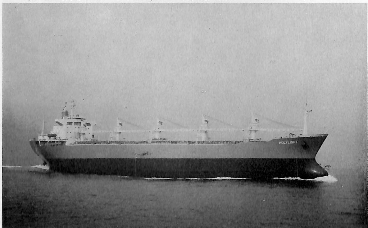
HOLY LIGHT (ばら積貨物船) 船主 Holy Co. Lt. (リベリア) 造船所 佐野安船渠株式会社 総噸数 22,246.19噸 遠洋 船級 AB 載貨重量 41,102噸 全長 183.675m 長(垂) 173.00m 幅(型) 27.00m 深(型) 12.107m 吃水 12.107m 凹甲板船 主機 住友スルザー7RND76型ディーゼル機関1基 出力 14,000PS ×122RPM 航続距離 16,000海里 速力 15.5ノット 汽罐 コ克蘭型7kg/cm 2 ×1 発電機 AC410KVA×450V ×3 貨物倉(ベール) 44,949.4m 3 (グレーン) 53,674.6m 3 乗員 40名 工期 49-7-2, 49-9-25, 49-11 -28
