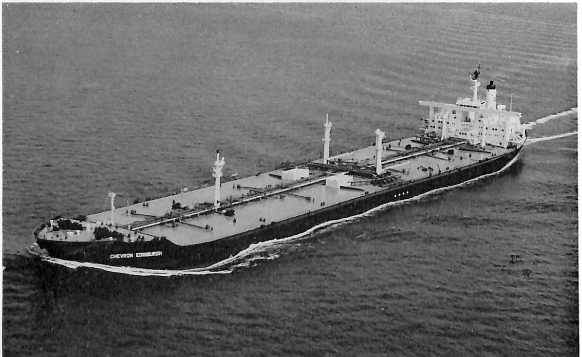
CHEVRON EDINBURGH (油槽船) 船主 Chevron Transport Corporation. (リベリア) 造船所 三菱重工業長崎造船所 総噸数 118,178.40噸 純噸数 100,270噸 遠洋 船級 AB 載貨重量 264,096Lt 全長 338.629m 長(垂) 320.00m 幅(型) 53.60m 深(型) 26.40m 吃水 67'-5 \frac{3}{8} " 船首楼付平甲板船 主機 三菱2段減速機付タービン1基 出力 34,000PS×90RPM 燃料消費量 165t/d 速力 15.4ノット 汽罐 三菱CEV2M-8W×1 発電機 1,500KW×AC450V×1,800rpm 貨油倉 320,552.1m 3 清水倉 372.5m 3 燃料油倉 5,300m 3 乗員 58名, 外8名 工期 49-3-14, 49-5-31, 49-10-2
