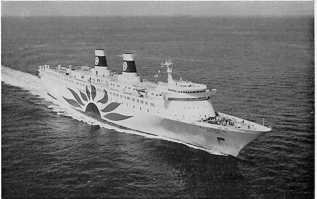
さんふらわあ11 (カーフェリー) 船主 日本高速フェリー株式会社 造船所 (株)来島どっく・大西工場 総噸数 13,598.50噸 純噸数 7,574.82噸 近海 船級 JG 載貨重量 3,111噸 全長 195.81m 長(垂) 170.00m 幅(型) 24.00m 深(型) 16.10m 吃水 6.622m 満載排水量 14,241噸 多層甲板型 主機 川崎MAN V9V52/55 型ディーゼル機関1基 出力 2×16,200PS×415RPM 燃料消費量 119.9t/d 航続距離 4,500海里 速力 25.0 ノット 汽罐 サンロッド油焚 4,500kg/h×8kg/cm 2 G 発電機 AC450V×1,437.5KVA×4 原動機 4×1,730PS ×720rpm 清水倉 1,017.13m 3 燃料油倉 720.48m 3 乗員 86名,旅客 1,218名 工期 49-12-4, 49-4-23, 49-9-9
