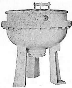
ライスボイラー
