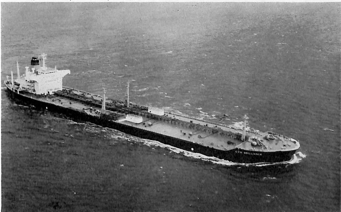
CYS BRILLIANCE (油槽船) 船主 Transworld No.5 Tanker Service Inc. (リベリア) 造船所 常石造船株式会社 総噸数 43,441.18噸 純噸数 31,082.33噸 遠洋 船級 BV 載貨重量 89,965噸 全長 246.509m 長(垂) 236.000m 幅(型) 39.600m 深(型) 18.450m 吃水 13.528m 満載排水量 106,944噸 船首楼付平甲板型 主機 IHI-スルザー 8RND90型ディーゼル機関1基 出力 20,880PS×117.8RPM 燃料消費量 79.9t/d 航続距離 17,400海里 速力 15.60ノット 汽罐 IHI 2胴式水管ボイラー 50,000kg/hr 発電機 D 640KW×2, T 680KW×1 原動機 1,000PS×2, 1,070PS×1 貨油倉 110,227.8m 3 清水倉 502.9m 3 燃料油倉 F 4,136.8m 3 D 430.4m 3 乗員 50名(含予備2名) 工期 49-5-2, 49-7-20, 49-10-29
