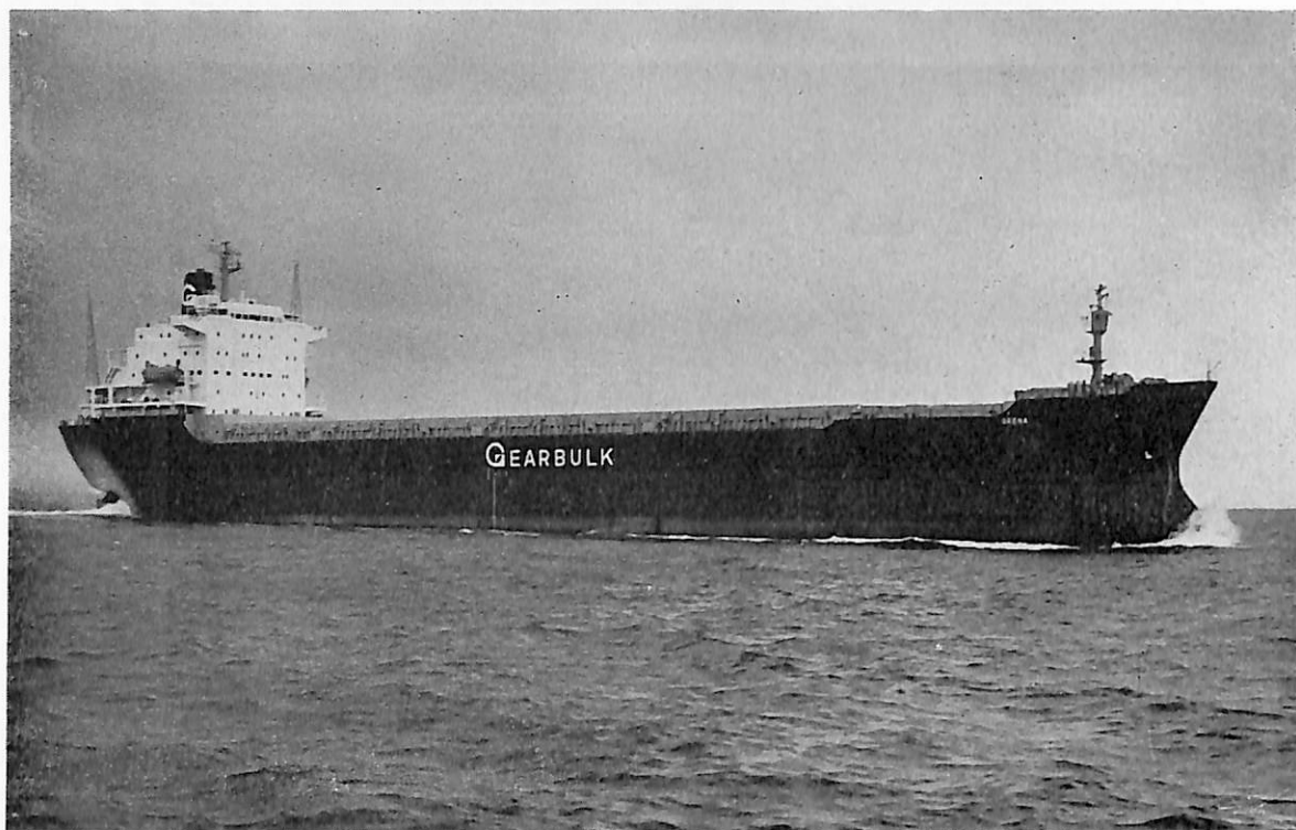
GRENA (ばら積貨物船) 船主 A/S J.Ludwig Mowinckels Rederi.(ノルウェー) 造船所 日本海重工業株式会社 総噸数 24,997.36噸 純噸数 13,299.32噸 遠洋 船級 NV 載貨重量 38,614噸 全長 182.00m 長(垂) 174.00m 幅(型) 29.00m 深(型) 16.10m 吃水 11.591m 満載排水量 49,417噸 凹甲板船尾機関型 主機 三井 B&W7K74EF型ディーゼル機関1基 出力 11,900PS×120RPM 燃料消費量 A 3.15t/d C 46.6t/d 航続距離 15,600海里 速力 14.5ノット 汽罐 サンロッドCPDB-15, 1,500kg/h×7kg/cm 2 G 発電機 450V×812.5 KVA(650KW)×3 貨物倉(ベール) 40,745m 3 (グリーン) 41,684m 3 清水倉 283.5m 3 燃料油倉 F 2,321.4m 3 D 210.9m 3 乗員 38名 工期 49-5-31, 49-9-14, 49-12-3
