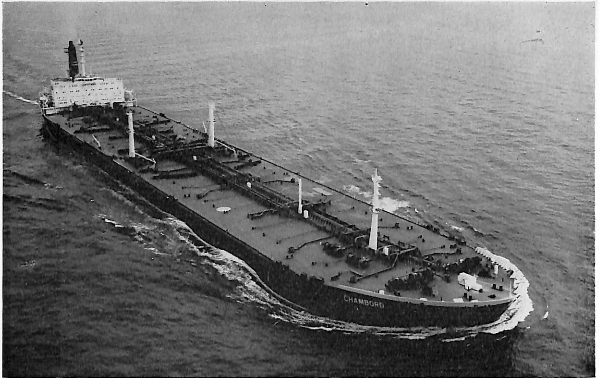
CHAMBORD (油槽船) 船主 Coclote De Developpment De Transpoft. (仏) 造船所 三菱重工業・長崎造船所 総噸数 131,627.58噸 純噸数 114,335.40噸 遠洋 船級 BV 載貨重量 276,658噸 全長 338.612m 長(垂) 323.00m 幅(型) 53.60m 深(型) 26.40m 吃水 20.6805m 平甲板船 主機 三菱2段減速機付タービン1基 出力 34,000PS×90RPM 燃料消費量 172t/d 航続距離 24,660海里 速力 15.4ノット 汽罐 MMI, CE. V 2 M-8W型×1 発電機 1,460KW×AC450×1,800rpm×2 貨油倉 347,618.0m 3 清水倉 422.5m 3 燃料油倉 12,604.0m 3 乗員 39名, 外8名 工期 49-3-15, 49-6-14, 49-10-3
