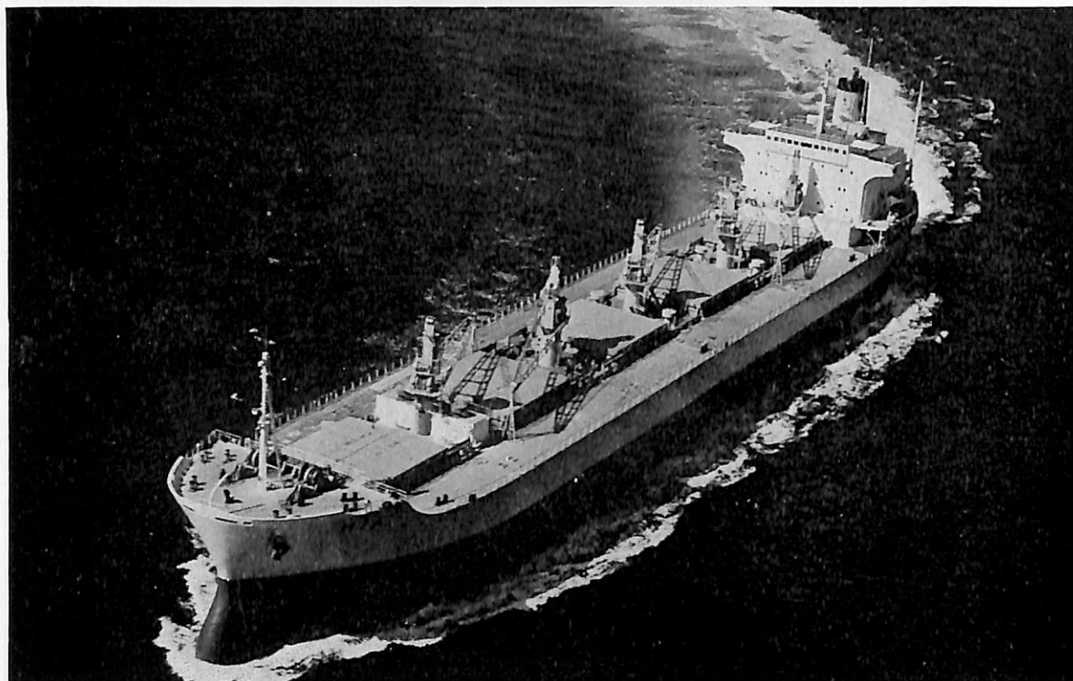
MIA (ばら積貨物船) 船主 Marinstinto Armadora S.A. (リベリア) 造船所 株式会社大阪造船所 総噸数 14,522.91噸 純噸数 8,864.23噸 遠洋 船級 LR 載貨重量 27,439噸 全長 169.60m 長(垂) 163.00m 幅(型) 26.30m 深(型) 13.60m 吃水 9.622m 満載排水量 34,133噸 船首楼付平甲板船 主機 IHIスルザー 7 RND68型ディーゼル機関1基 出力 10,395PS×144.8RPM 燃料消費量 41.5t/d 航続距離 15,800海里 速力 15.000ノット 汽罐 コクラン罐 7kg/cm 2 ×1 発電機 AC450V500KVA×3 原動機 ダイハツ6PSHT-26D590 BHP×3 貨物倉(ベール) 32,047m 3 (グリーン) 32,363m 3 清水倉 345.7m 3 燃料油倉 2,022.4m 3 乗員 36名 工期 49-6-1, 49-8-28, 49-11-12
