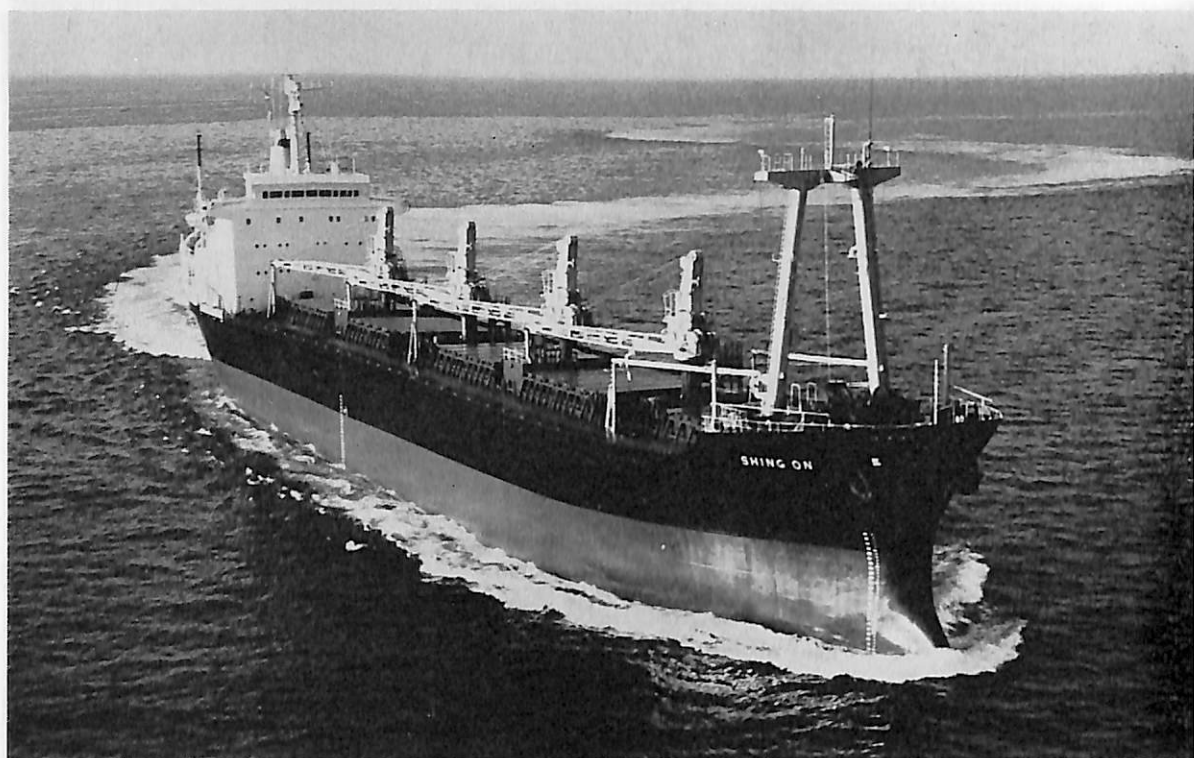
SHING ON (ばら積貨物船) 船主 Rose Wood Navigation Company, S.A. (パナマ) 造船所 日本鋼管・清水造船所 総噸数 12,692.33噸 純噸数 8,388噸 遠洋 船級 AB 載貨重量 22,070噸 全長 155.76m 長(垂) 145.70m 幅(型) 22.86m 深(型) 13.60m 吃水 9.99m 満載排水量 26,901噸 凹甲板船 主機 住友スルザー 6 RND68型ディーゼル機関1基 出力 8,100PS×133RPM 燃料消費量 31.5t/d 航続距離 14,100海里 速力14.7ノット 汽罐 コンポジット罐1基 発電機 310KW×AC450V×720rpm×2 貨物倉(ベール) 25,067.1m 3 (グレーン) 29,098.5m 3 清水倉 84.00m 3 燃料油倉 1,383.00m 3 乗員 37名 工期 49-7-25, 49-10-15, 49-12-17
