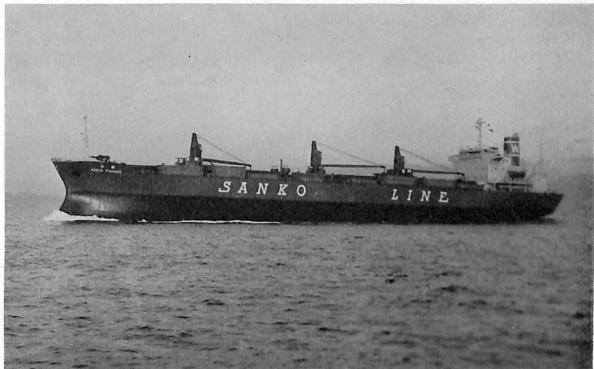
WORLD FINANCE (自動車兼ばら積貨物船) 船主 Liberian Athene Transports, Inc. (リベリア) 造船所 株式会社大阪造船所 総噸数 20,513.25噸 純噸数 14,481噸 遠洋 船級 AB 載貨重量 33,034噸 全長 185.371m 長(垂) 175.000m 幅(型) 26.000m 深(型) 16.100m 吃水 11.385m 満載排水量 42,732噸 船首楼付平甲板船 主機 IHI スルザー6RND76型ディーゼル機関1基 出力 10,800PS×117.8RPM 燃料消費量 43.25t/d 航続距離 15,600海里 速力 14.8ノット 汽罐 堅型横煙管式コクラン型コンボジットボイラー1台 発電機 AC450V×500KVA×3 原動機 ヤンマー6UL-UT 590BHP×720rpm×3 貨物倉(ベール) 40,088m 3 (グリーン) 41,396m 3 清水倉 465.4m 3 燃料油倉 2,137.9m 3 乗員 38名 工期 48-7-10, 49-10-9, 49-12-13
