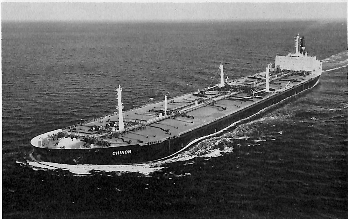
CHINON (油槽船) 船主 Societ De Development De Transport.(仏) 造船所 三菱重工業・長崎造船所 総噸数 131,627.58噸 純噸数 114,335.40噸 遠洋 船級 BV 載貨重量 269,709噸 全長 338.612m 長(垂) 323.00m 幅(型) 53.60m 深(型) 26.40m 吃水 20.6805m 平甲板船 主機 三菱2段減速裝置付タービン1基 出力 34,000PS×90RPM 燃料消費量 172t/d 航続距離 24,660海里 速力 15.4ノット 汽罐 三菱CE, 2VM 8W型×2 発電機 1,400KW, AC450V×1,800rpm×2 貨油倉 347,618.0m 3 清水倉 422.5m 3 燃料油倉 12,604.0 m 3 乗員 39名(外8) 工期 49-5-29, 49-9-3, 49-12-10
