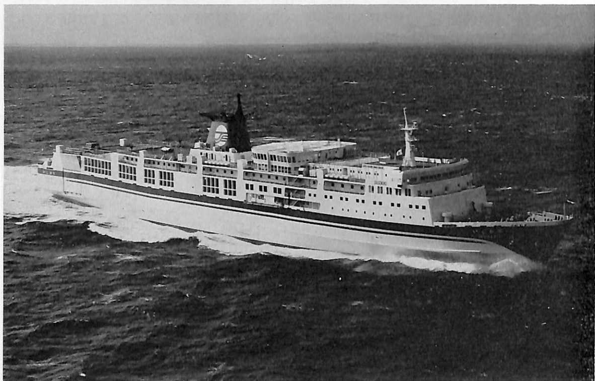
いしかり(自動車航送旅客船) 船主 太平洋沿海フェリー株式会社 造船所 内海造船・瀬戸田工場 総噸数 11,880.37噸 純噸数 6,075.19噸 近海 載貨重量 4,092噸 全長 175.565m 長(垂) 162.00m 幅(型) 24.00m 深(型) 9.70m 吃水 6.472m 満載排水量 12,880噸 全通船楼二層甲板型 主機 三菱MAN-V7V52/55 型ギヤードディーゼル機関2基 出力 2 \times 11,720 \text{ PS} \times 407/181.5 \text{ RPM} 燃料消費量 94t/d 航続距離 3,406海里 速力 23.0ノット 汽罐 乾燃式船用丸ボイラー 7 \text{ kg/cm}^2 \times 3,950 \text{ kg/h} \times 1 発電機 1,100 \text{ KVA} \times \text{AC}450 \text{ V} \times 3 原動機 1,300 \text{ PS} \times 720 \text{ RPM} \times 3 旅客定員 905名, 車両 8tトラック 130台, 乗用車 105台 清水倉 859m 3 燃料油倉 740 m 3 乗員 70名 工期 49-4-3, 49-9-19, 49-12-23 航路 大分-名古屋-仙台-苫小牧
