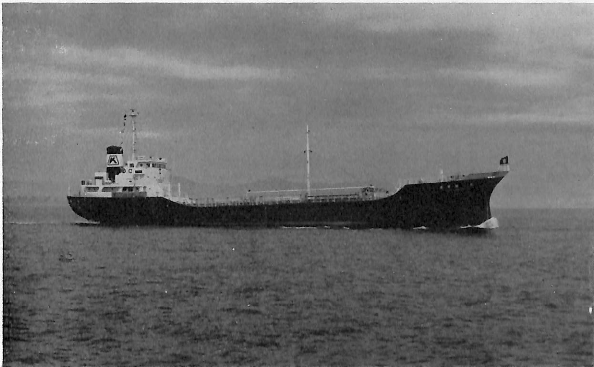
第二観幸丸 (油槽船) 船主 船舶整備公団・丸幸海運株式会社 造船所 徳島造船産業株式会社 総噸数 999.16噸 純噸数 702.99噸 沿海 載貨重量 2,387.00噸 全長 77.90m 長(垂) 71.00m 幅(型) 12.00m 深(型) 5.50m 吃水 5.011m 満載排水量 3,131.00噸 凹甲板型 主機 横田KSLH-633型ディーゼル機関1基 出力 1,700PS×332RPM 燃料消費量 6.1t/d 航続距離 2,000海里 速力 11.5ノット 汽罐 タクマWHO50型619kg/h 発電機 100KVA×2 貨油倉 2,871.18m 3 清水倉 81.07m 3 燃料油倉 79.86m 3 乗員 12名 工期 49-8-5, 49-10-29, 49-12-17
