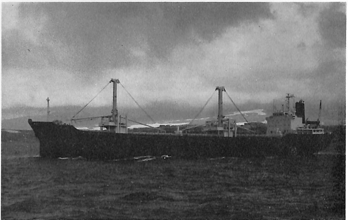
大 旺 丸 (貨物船) 船主 丸紅株式会社 造船所 檜崎造船株式会社 総噸数 10,131.39噸 純噸数 5,932.49噸 遠洋 船級 NK 載貨重量 15,931.2Lt 全長 139.960m 長(垂) 129.500m 幅(型) 21.400m 深(型) 12.550m 吃水 9.535m 満載排水量 20,856.9噸 凹甲板船 主機 神戸発 動機 8 UEC52/105 D型ディーゼル機関 1基 出力 7,200PS×169RPM 燃料消費量 28.6t/d 航続距離 14,710海 里 速力 14.1ノット 汽罐 コクランコンポジット型 7kg/cm 2 800kg/hr 発電機 360KVA×AC445V×2 原動機 470PS×900rpm×2 貨物倉(ベール) 19,851.4m 3 (グレーン) 20,782.4m 3 清水倉 415.0m 3 燃料油倉 A 193.6 m 3 C 1,320.9m 3 乗員 29名 工期 49-6-12, 49-9-19, 49-12-9
