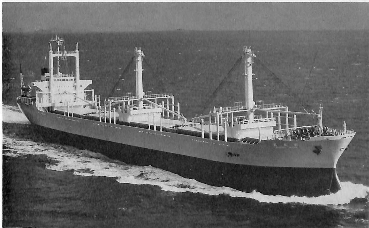
昭成丸 (貨物船) 船主 一成汽船株式会社 造船所 尾道造船株式会社 総噸数 16,319.56噸 純噸数 10,397.27噸 遠洋 船級 NK 載貨重量 27,709.40噸 全長 172.35 m 長(垂) 163.00 m 幅(型) 24.60 m 深(型) 14.20 m 吃水 10.224 m 満載排水量 34,220.00噸 主機 三菱スルザー7R ND68型ディーゼル機関1基 出力 10,400PS×140 RPM 燃料消費量 39.6t/d 航続距離 13,180海里 速力14.6ノット 汽罐 立円筒型 発電機 AC450 V, 3φ, 60Hz, 380 KW×3 貨物倉(ベール) 38,468.49m 3 (グレーン) 34,393.04m 3 清水倉 382.51m 3 燃料油倉 1,649.60m 3 乗員 29名 工期 49-6-9, 49-9-16, 49-12-14
