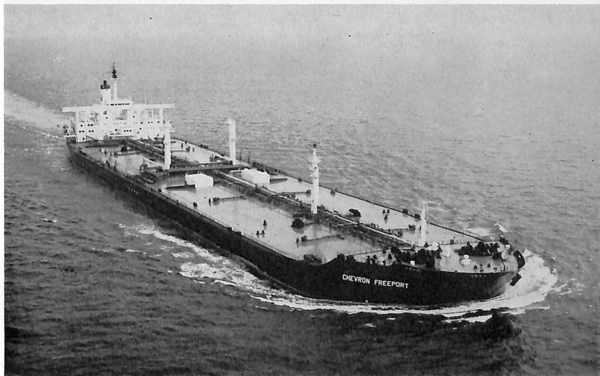
CHEVRON FREEPORT (油槽船) 船主 Chevron Navigation Corporation. (リベリア) 造船所 三菱重工業・長崎造船所 総噸数 118,209.02噸 純噸数 100,300噸 遠洋 船級 AB 載貨重量 264,000噸 全長 338.629 m 長(垂) 320.00 m 幅(型) 53.60 m 深(型) 26.40 m 吃水 67'-5 3 / 8 " 船首楼付平甲板船 主機 三菱2段減速機付タービン1基 出力 34,000PS×90RPM 燃料消費量 165t/d 航続距離 25,300海里 速力 15.4ノット 汽罐 三菱CE, V2 M-8 W型×2 発電機 1,500kW, AC450V, 1,800 rpm×2 貨油倉 320,552.1m 3 清水倉 272.5m 3 燃料油倉 12,296.6m 3 乗員 41名(外8名) 工期 49-4-25, 49-7-11, 49-11-27
