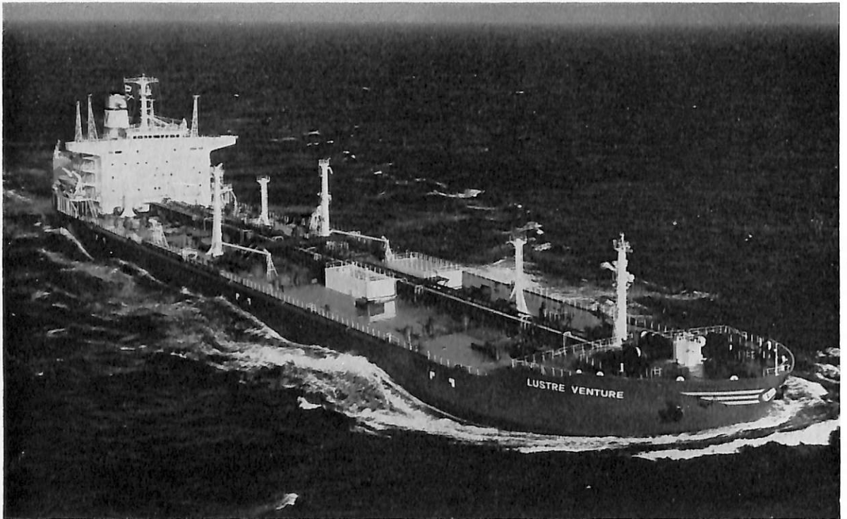
LUSTRE VENTURE (油槽船) 船主 Lustre Carriers Inc. (リベリア) 造船所 三井造船・玉野造船所 総噸数 31,863.12噸 純噸数 22,269.64噸 遠洋 船級 NK 載貨重量 67,120噸 全長 215.000m 長(垂) 205.000 m 幅(型) 35.500m 深(型) 17.500m 吃水 13.0305m 満載排水量 80,322噸 船首樓付平甲板船 主機 三井 B &W 7 K84EF型ディーゼル機関1基 出力 14,900BHP×108RPM 燃料消費量 69t/d 航続距離 13,200海里 速 力 15.0ノット 汽罐 三井 2 胴式水管ボイラー 40,000kg/h×16kg/cm 2 ×1 発電機 760KW×2 原動機 ヤンマー 6GL ST 1,100BHP 貨油倉 79,358.9m 3 清水倉 397.4m 3 燃料油倉 3,119.7m 3 乗員 51名 工期 49-6-27, 49- 9-6, 49-12-20
