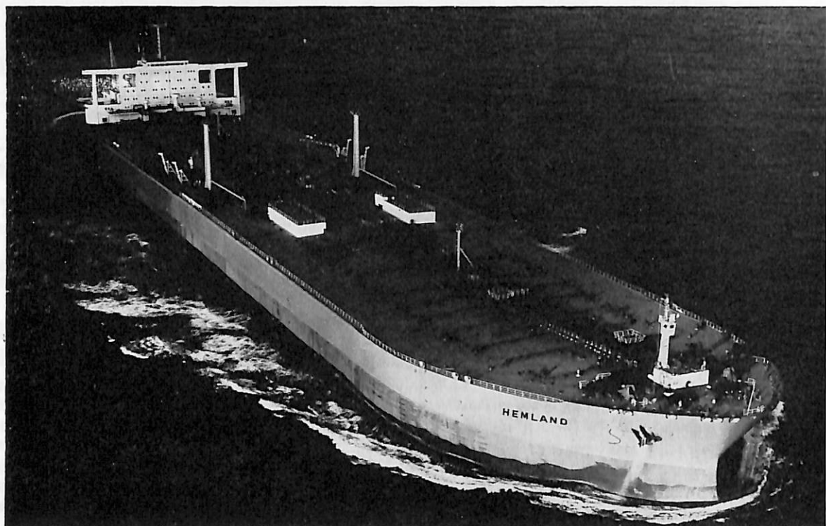
HEMLAND (油槽船) 船主 Tirfing Steamship Company. (スウェーデン) 造船所 三井造船・千葉造船所 総噸数 190,367.16噸 純噸数 152,733.68噸 遠洋 船級 LR 載貨重量 372,200噸 全長 363.657 m 長(垂) 348.000 m 幅(型) 63.400 m 深(型) 28.700 m 吃水 22.654 m 満載排水量 424,571噸 平甲板船 主機 三井 造船スタルラバルスチームエンジン 1基 出力 45,000 PS×80 RPM 燃料消費量 232 t/d 航続距離 25,900海里 速力 16.40ノット 汽罐 三井FW, MSD型×2 発電機 1,400 KW×1, 750 KW×2 貨油倉 459,132.2 m 3 清水倉 490.6 m 3 燃料油倉 16,996.2 m 3 乗員 51名 工期 49-2-26, 49-10-5, 49-12-20
