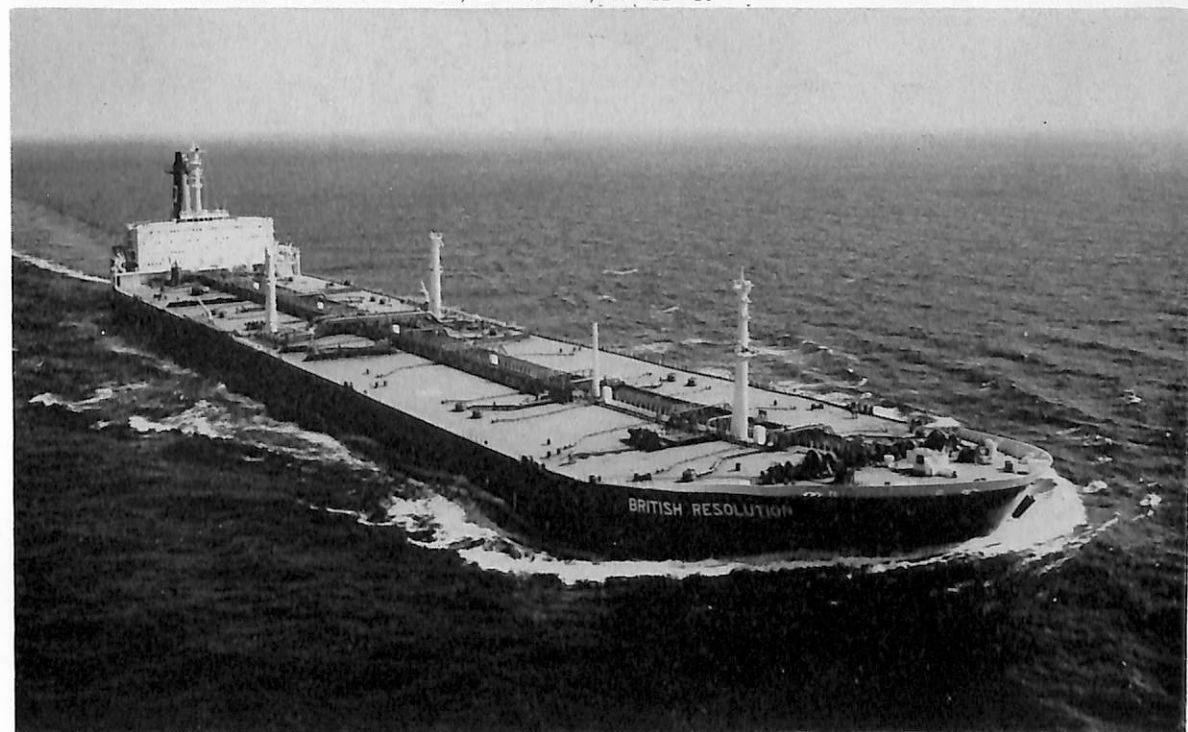
BRITISH RESOLUTION (油槽船) 船主 Bp Midway Tanker Co.Ltd.(英) 造船所 三菱重工業・長崎造船所 総噸数 133,034.80噸 純噸数 108,853.28噸 遠洋 船級 LR 載貨重量 270,668噸 全長 338.612m 長(垂) 323.00m 幅(型) 53.60m 深(型) 26.40m 吃水 20.6795m 平甲板型 主機 三菱2段減速裝置付タービン1基 出力 30,000PS×88RPM 燃料消費量 152t/d 航続距離 24,650海里 速力 14.8ノット 汽罐 三菱CE, V2M 2W型×2 発電機 1,400KW, AC450V 1,800rpm×2 貨油倉 347,617.8m 3 清水倉 422.5m 3 燃料油倉 12,874.4 m 3 乗員 46名(外7) 工期 49-3-12, 49-7-5, 49-11-8
