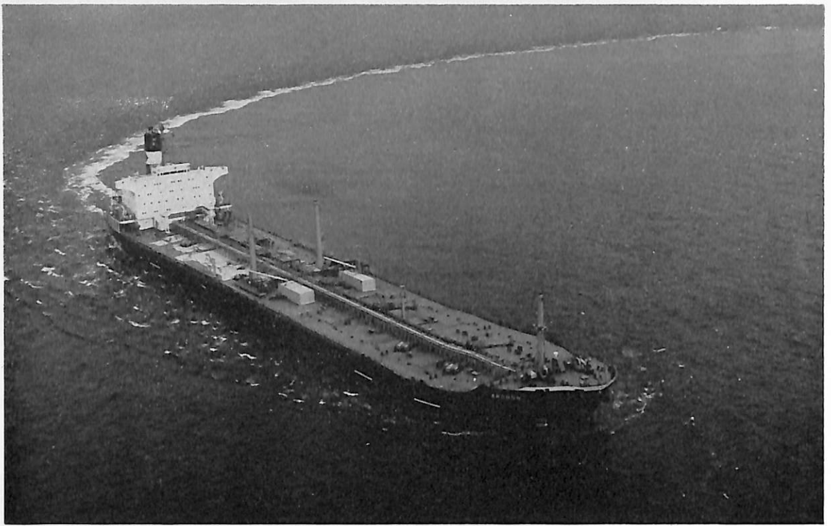
ARCHON (油槽船) 船主 Inca Compania Naviera S.A. (リベリア) 造船所 日本鋼管・鶴見造船所 総噸数 56,988.03噸 純噸数 44,777.58噸 遠洋 船級 LR 載貨重量 121,500Lt 全長 264.000m 長(垂) 252.000 m 幅(型) 38.000m 深(型) 23.000m 吃水 57' -1" 満載排水量 143,195噸 船主樓付平甲板船 主機 住友スル ザー8 RND90型ディーゼル機関1基 出力 20,800PS×118RPM 燃料消費量 76.4t/d 航続距離 21,000海里 速力 15.25ノット 汽罐 2 胴水管ボイラー 15.5kg/cm 2 飽和 発電機 640KW×450V×3 原動機 ディーゼルエンジン 貨油倉 149,784m 3 清水倉 459m 3 燃料油倉 4,873m 3 乗員 41名 工期 49-5-13, 49-8-9, 49-11-28
