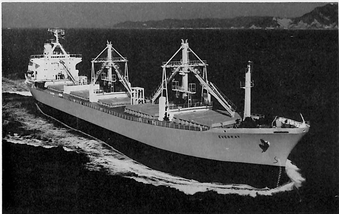
EVERRAY (貨物船) 船主 Marine Fortune Ltd.(パナマ) 造船所 石川島播磨重工業・東京工場 総噸数 13,197.62噸 純噸数 9,463.90噸 遠洋 船級 LR 載貨重量 22,622噸 全長 164.33 m 長(垂) 155.448 m 幅(型) 22.86 m 深(型) 13.56 m 吃水 9.849 m 平甲板型 主機 IHI-ビールスタック16PC-2V型ディーゼル機関1基 出力 7,200PS×482 RPM 燃料消費量 28.1t/d 航続距離 15,000海里 速力 15.0ノット 汽罐 8.5kg/cm 2 G×2.5 t/h 発電機 260KW×AC450 V×900 rpm×1, 360KW×AC450 V×900 rpm×2 貨物倉(ベール) 29,950.9m 3 (グレーン) 30,907m 3 清水倉 201.4m 3 燃料油倉 1,540m 3 乗員 37名 工期 49-7-31, 49-10-1, 49-12-5
