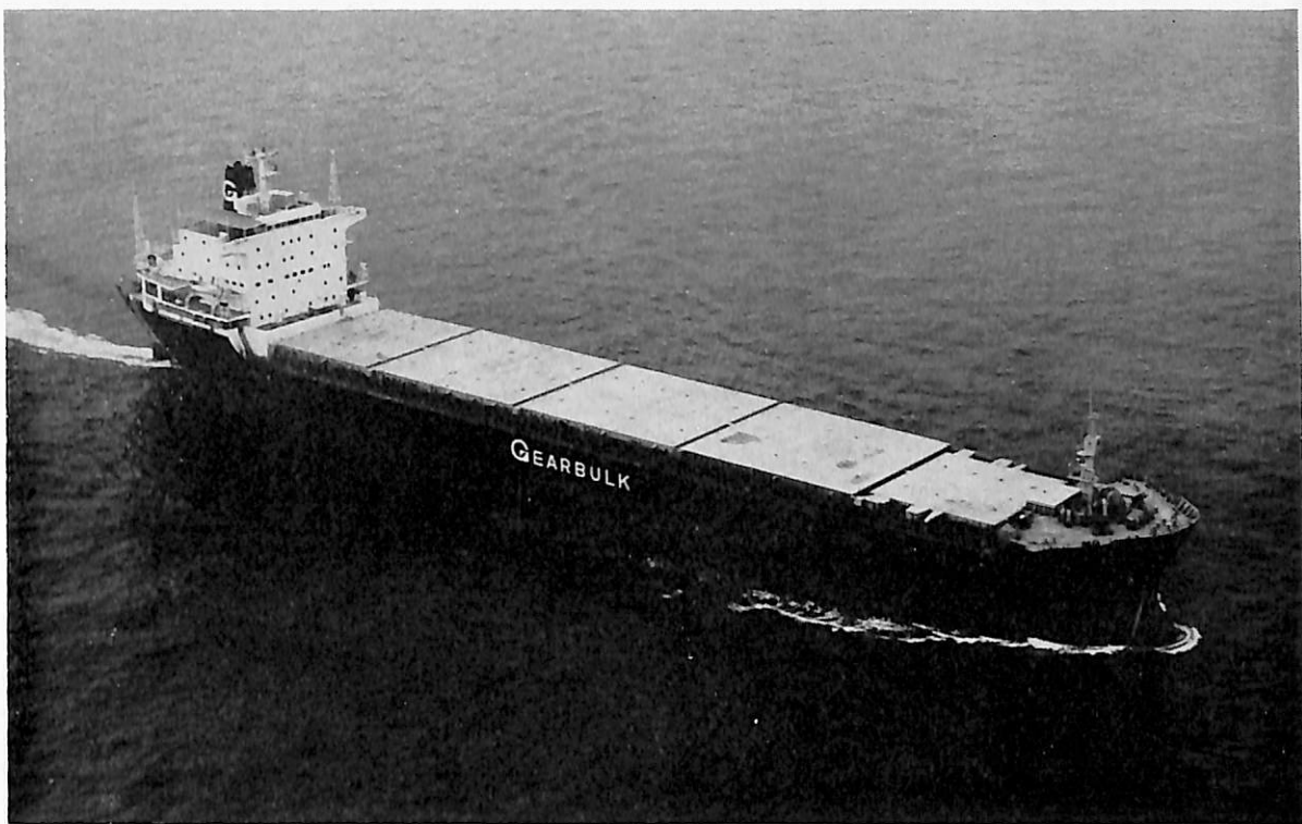
TSURU ARROW (ばら積貨物船) 船主 Kriship Shipping Co., Ltd. (英) 造船所 三井造船・藤永田造船所 総噸数 24,997.36噸 純噸数 13,293.36噸 遠洋 船級 NV 載貨重量 38,069Lt 全長 182.000m 長(垂) 174.000 m 幅(型) 29.000m 深(型) 16.100m 吃水 11.611m 満載排水量 49,509噸 凹甲板船 主機 三井B&W 7 K74 EF型ディーゼル機関×1基 出力 11,900BHP×120RPM 燃料消費量 A 3.15t/d C 48.07t/d 航続距離 15,000 海里 速力 14.5ノット 汽罐 HS 159m 2 , 1,600kg/hr×7kg/cm 2 発電機 1,000BHP×3 原動機 タイハツ8PSHT b-26 D型 貨物倉(ランバー) 40,745m 3 (グレーン) 41,684m 3 清水倉 258.5m 3 燃料油倉 2,205.2t 乗員 37名 工期 49-6-21, 49-9-10, 49-12-10 設備 25t ガントリークレーン×2
