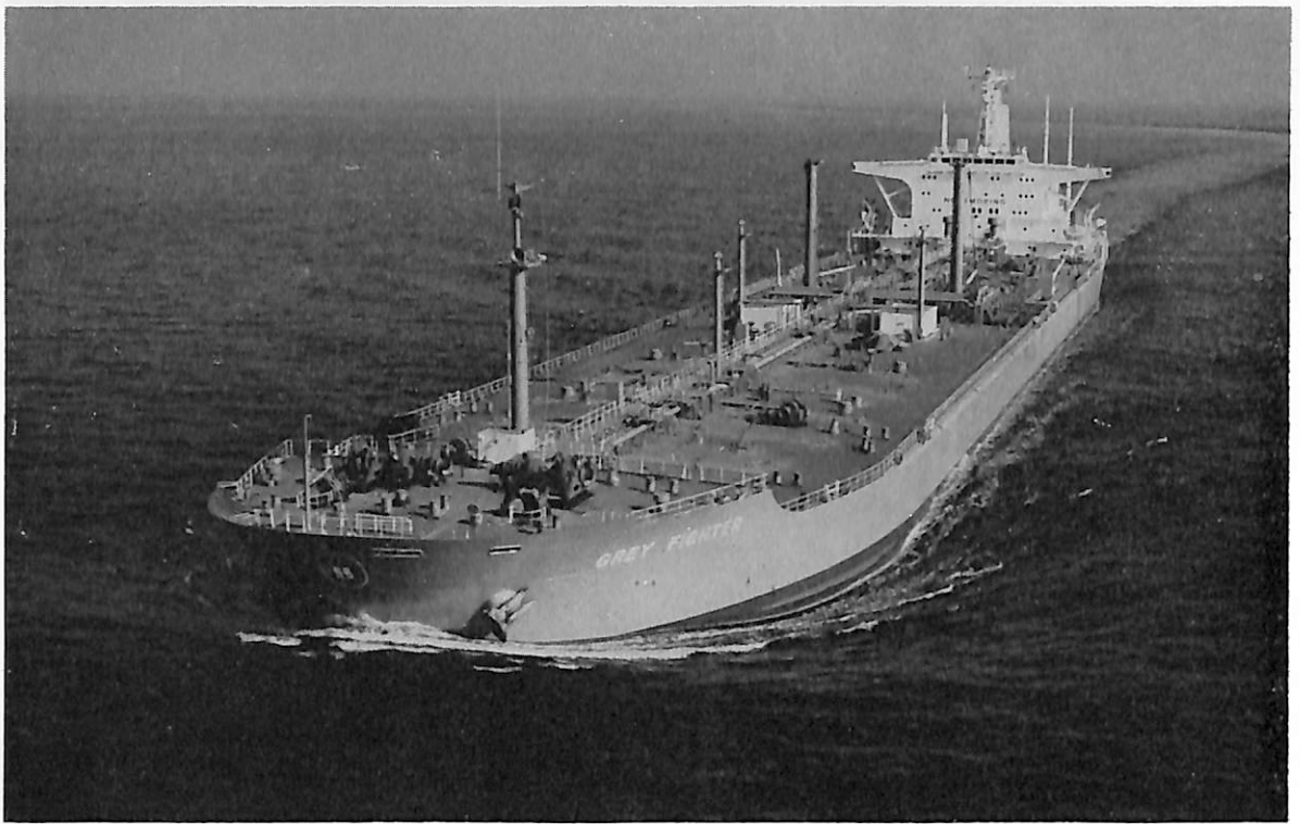
GREY FIGHTER (油槽船) 船主 I. C. B (Ltasing) Ltd. (英) 造船所 三菱重工業・広島造船所 総噸数 67,201.76噸 純噸数 46,256.13噸 遠洋 船級 LR 載貨重量 123,894噸 全長 260.62m 長(垂) 247.00m 幅(型) 40.60m 深(型) 22.30m 吃水 16.834m 満載排水量 143,534噸 平甲板船 主機 三菱スル ザー9 RND90型ディーゼル機関1基 出力 23,490PS×118RPM 燃料消費量 86.3t/d 速力 15.80ノット 汽 罐 三菱CE-2 発電機 450KW, 937.5 KVA, 750KW, 60Hz, 720rpm×3 貨油倉 147,755.3m 3 清水倉 486.6m 3 燃料油倉 6,868.1m 3 乗員 40名 工期 49-6-25, 49-9-19, 49-12-20
