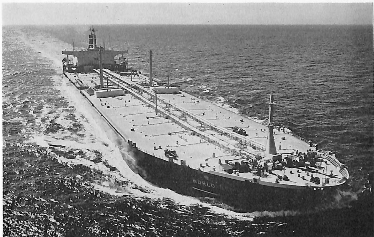
WORLD RENOWN (世銘) (油槽船) 船主 Liberian Jaguar Transports Inc. (リベリア) 造船所 日本鋼管・津造船所 総噸数 118,475.06噸 純噸数 99,119.34噸 遠洋 船級 LR 載貨重量 262,222噸 全長 332.668 m 長(垂) 314.000 m 幅(型) 54.800 m 深(型) 26.400 m 吃水 20.576 m 満載排水量 299,709噸 平甲板船 主機 三菱クロスコンパウンド2段減速スチームタービンMS36-2型ディーゼル機関1基 出力 36,000PS×85RPM 燃料消費量 179.4t/d 航続距離 22,660海里 速力 15.64ノット 汽罐 85,000kg/h×61.5kg/cm 2 g×2 発電機 1,880kW×450V×1, 1,000kW×450V×2 原動機 タービン, ディーゼル 貨油倉 319,366.5m 3 清水倉 593.4m 3 燃料油倉 11,882.6m 3 乗員 50名 工期 49-4-8, 49-7-18, 49-11-11
