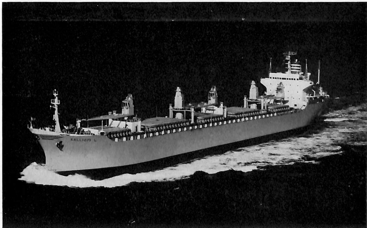
KALLIOPI L. (ばら積貨物船) 船主 Sunrise Co., Ltd. (ギリシャ) 造船所 株式会社村造船所 総噸数 15,938.23噸 純噸数 11,158噸 遠洋 船級 AB 載貨重量 26,650Lt 全長 178.52m 長(垂) 167.00 m 幅(型) 22.90m 深(型) 14.50m 吃水 10.403m 満載排水量 33,490噸 凹甲板型 主機 三菱スルザー7RND68 型ディーゼル機関1基 出力 9,820PS×142RPM 燃料消費量 A 2.0t/d C 36.8t/d 航続距離 18,400海里 速力 15.0ノット 汽罐 7kg/cm 2 , 1,200kg/h, 169.6°C 1台 発電機 AC 500KVA×450V×3 原動機 625PS×600RPM 貨物倉(ペール) 32,595m 3 (グレーン) 34,247m 3 清水倉 126.9m 3 燃料油倉 2,034.1m 3 乗員 36名 工期 49-5 -28, 49-9-11, 49-12-17
