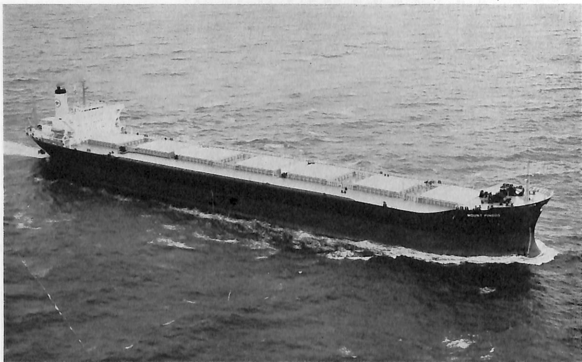
MOUNT PINDOS (ばら積貨物船) 船主 Netropolitan Bulk Carriers Corp. (ギリシャ) 造船所 日立造船・舞鶴工場 総噸数 33,147.19噸 純噸数 26,125噸 遠洋 船級 AB 載貨重量 60,428Lt 全長 225.055m 長(垂) 215.00m 幅(型) 32.20m 深(型) 17.80m 吃水 40'-10 1/2" 満載排水量 71,815噸 船首楼付平甲板型 主機 日立スルザー 7RND76型ディーゼル機関1基 出力 12,600PS×118RPM 燃料消費量 48.07t/d 航続距離 23,530海里 速力 14.80ノット 汽罐 日立フレミングボイラー×3 発電機 475KVA×AC450V×60Hz×3 貨物倉(グレーン) 82,507.3m 3 清水倉 15,552ft 3 燃料油倉 127,051ft 3 乗員 39名 工期 49-2-25, 49-9-4, 49-11-20
