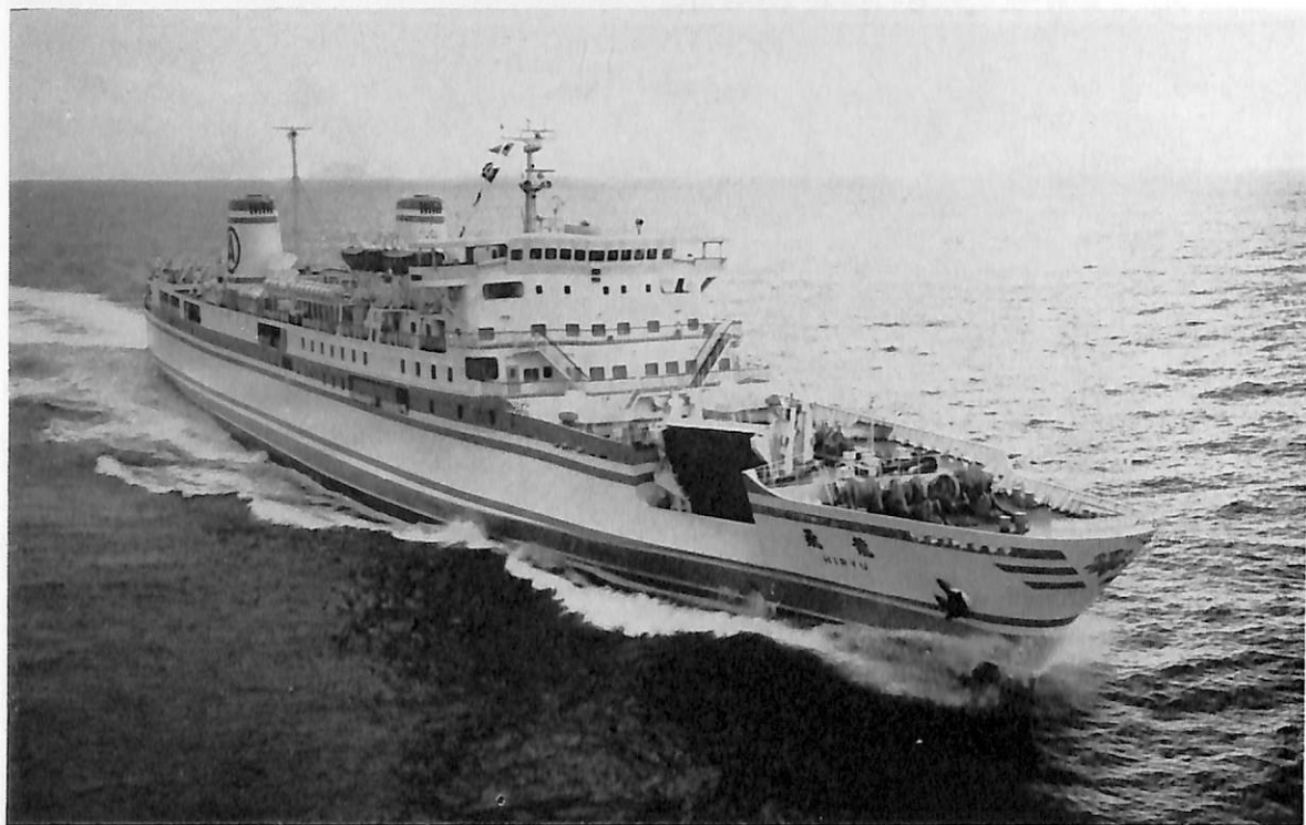
飛 龍(自動車航送旅客船) 船主 有村産業株式会社 造船所 三菱重工工業・下関造船所 総噸数 8,156.07噸 純噸数 3,261.10噸 近海 載貨重量 294.7噸 全長 166.63m 長(垂) 156.00m 幅(型) 22.00/21.20m 深(型) 8.00m 吃水 5.80m 満載排水量 10,943噸 全通船楼船 主機 三菱MAN-V8V52/55単動V型ディーゼル機関1基 出力 14,400 \text{ PS} \times 415 \text{ RPM} 燃料消費量 113t/d 航続距離 5,000海里 速力 25ノット 汽罐 クレイトンRH6-300型 7 \text{ kg/cm}^2 \times 4,000 \text{ kg/h} \times 1 発電機 812.5 \text{ KVA}, \text{AC}440 \text{ V} \times 60 \text{ Hz} \times 4 自動車搭載数 8tトラック 76台, 乗用車 97台, 旅客 1,007名 清水倉 421.9m 3 燃料油倉 1,131.7 \text{ m}^3 乗員 47名 工期 48-12-19, 49-6-22, 49-11-29 航路 阪神-沖繩
