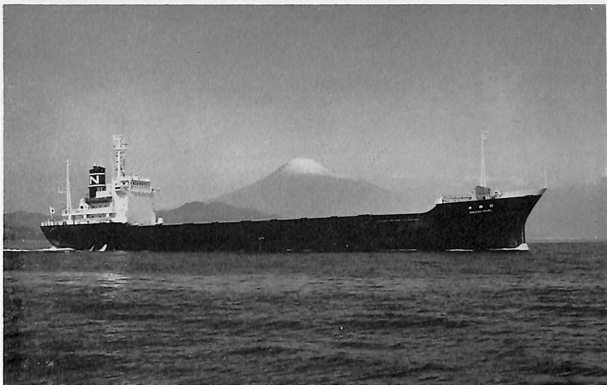
日興丸 (フルコンテナ船) 船主 日興海運株式会社・トーセイライン株式会社 造船所 株式会社三保造船所 総噸数 4,448.04噸 純噸数 2,625.49噸 近海 船級 NK 載貨重量 5,659.25噸 全長 119.00m 長(垂) 109.00m 幅(型) 17.80m 深(型) 8.20m 吃水 5.921m 満載排水量 8,228.47噸 船首尾楼付一層甲板船 主機 横田鉄工堅型単動4サイクルバンクピストン型、可逆転排気ターボチャージ及び空気冷却器付ディーゼル機関1基 出力 4,420軸PS×213RPM 燃料消費量 14t/d 航続距離 7,900海里 速力 14.0ノット 汽罐 水管式 4.6~6.5kg/cm 2 発電機 300PS×2 原動機 AC 445V×324A×2 清水倉 210.16m 3 燃料油倉 A 76.93m 3 B 391.70m 3 乗員 30名 工期 49-5-29, 49-10-4, 49-12-9
