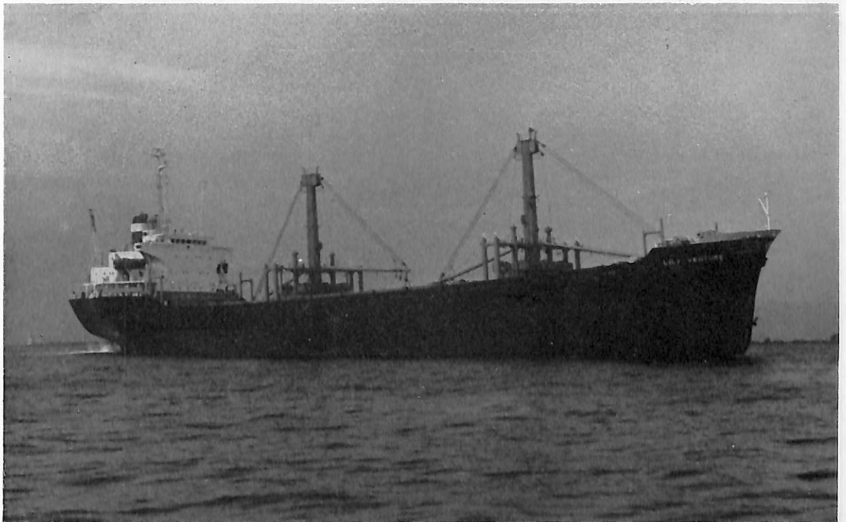
LILY VENTURE (貨物船) 船主 Lilyfield Co., Ltd. (リベリア) 造船所 福岡造船株式会社 総噸数 7,020.96噸 純噸数 4,654.73噸 遠洋 船級 BV 載貨重量 11,538.18Lt 全長 127.80m 長(垂) 119.00 m 幅(型) 20.50m 深(型) 10.30m 吃水 8.050m 満載排水量 15,158.00噸 凹甲板型 主機 神戸発動機6UE C52/105D型船用ディーゼル機関1基 出力 5,270PS×166RPM 燃料消費量 21t/d 航続距離 13,500海里 速 力 13.2ノット 汽罐 コクラン型 0.6t/h×1 発電機 250KW×AC60Hz×450V×720rpm×2 貨物倉(ベール) 13,911.75m 3 (グリーン) 14,721.84m 3 清水倉 585.89m 3 燃料油倉 1,613.57m 3 乗員 38名 工期 49-6-26, 49-10-28, 49-12-18
