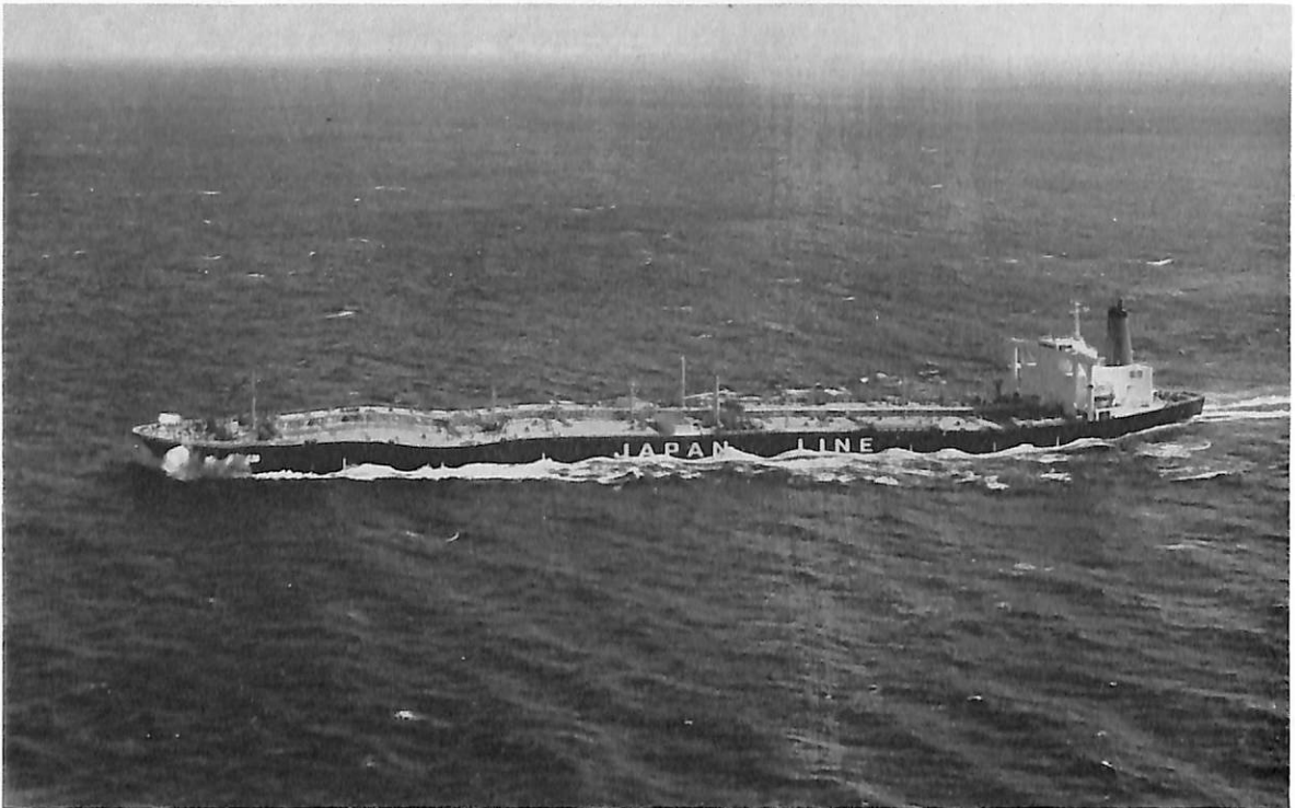
ジャパンバイオレット (油槽船) 船主 ジャパンライン株式会社 造船所 川崎重工業・坂出工場 総噸数 116,331.96噸 純噸数 88,868.19噸 遠洋 船級 NK 載貨重量 233,236噸 全長 319.93m 長(垂) 305.00 m 幅(型) 53.00m 深(型) 25.30m 吃水 19.653m 満載排水量 268,029噸 平甲板型 主機 川崎UA360 2段減 速歯車装置付船用タービン1基 出力 35,000PS×89RPM 燃料消費量 173.6t/d 航続距離 15,600海里 速力 16.39ノット 汽罐 川崎UMG70/56-UA 2胴水管式2基 発電機 1,600KW 2,000KVA, AC450Vタービン×1, 760KW 950KVA, AC 450Vディーゼル×2, 貨油倉 287,860.43m 3 清水倉 201.15m 3 燃料油倉 7,702.88m 3 乗員 43名 工期 49-3-23, 49-9-11, 49-12-17 ノズルプロペラ装備
