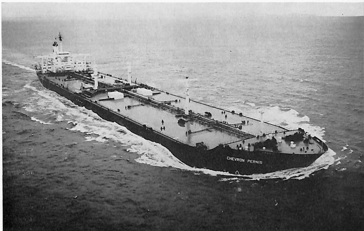
CHEVRON PERNIS (油槽船) 船主 Chevron Navigation Corporation. (リベリア) 造船所 三菱重工業・長崎造船所 総噸数 118,198.24 噸 純噸数 100,289 噸 遠洋 船級 AB 載貨重量 263,791Lt 全長 338.629 m 長(垂) 320.00m 幅(型) 53.60m 深(型) 26.40m 吃水 67' - 5%" 主機 三菱2段減速装置付タービン1基 出力 34,000PS×90RPM 燃料消費量 165t/d 航続距離 25,300海里 速力 15.4ノット 汽罐 三菱CE, V2M 8 W 型×2 61.2kg/cm 2 ×515.6°C 72,000kg/h 発電機 AC 450V, 1,500KW×1, 800rpm×1 貨油倉 320,552.1m 3 清水倉 372.5m 3 燃料油倉 12,296.6m 3 乗員 51名, 外8名 工期 49-6-7, 49-8-23, 49-12-20
