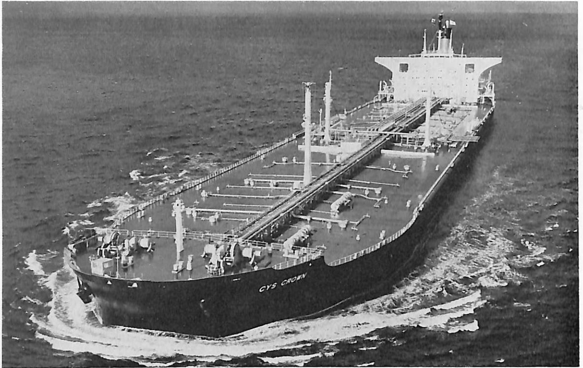
CYS CROW (原油輸送) 船主 Associated Tanker Transported, Inc. 造船所 佐世保重工業・佐世保造船所 総噸数 114,585.69噸 純噸数 94,646.35噸 遠洋 船級 NK 載貨重量 254,279Lt 全長 339.500m 長(垂) 324.000m 幅(型) 53.500m 深(型) 25.700m 吃水 20.000m 満載排水量 295,971噸 船首楼付平甲板型 主機 IHI 横型コンポジットタービン1基 出力 33,000SPS×87.4RPM 燃料消費量 9,973.1m 3 航続距離 19,500海 里 速力 15.21ノット 汽罐 佐世保FWMDM 79t/h×62kg/cm 2 G×515°C 発電機 440V AC 2,500KVA(2,000KW) 貨油倉 311,366.7m 3 清水倉 408m 3 燃料油倉 9,973.1m 3 乗員 52名 工期 49-6-5, 49-9-2, 49-12-23
