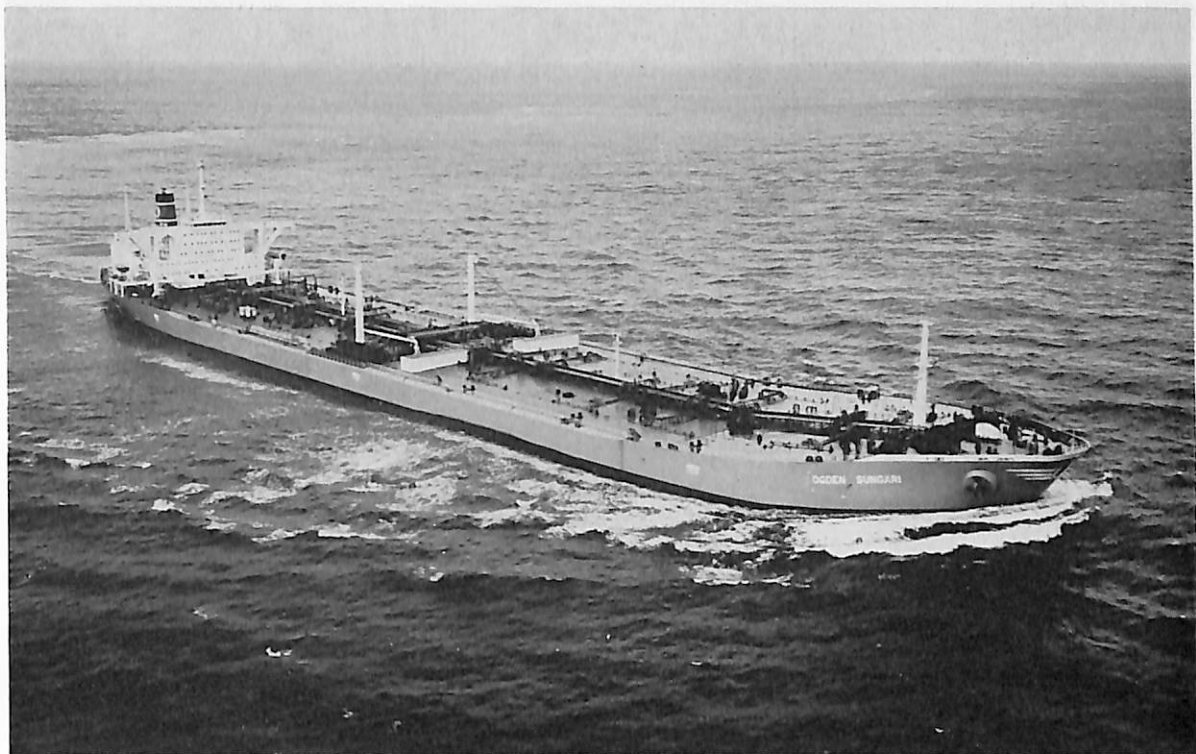
OGDEN SUNGARI (油槽船) 船主 Ogden Sungari Transport Inc. (リベリヤ) 造船所 住友重機械工業・追浜造船所 総噸数 124,085.53噸 純噸数 107,019噸 遠洋 船級 AB 載貨重量 275,933噸 全長 340.80m 長(垂) 324.00m 幅(型) 54.40m 深(型) 26.90m 吃水 21.040m 満載排水量 316,368噸 一層甲板型 主機 東洋タービン製住友スタラルラバルAP型タービン1基 出力 38,000PS×91RPM 燃料消費量 188t/d 航続距離 20,000海里 速力 16.25ノット 汽罐 二胴水管式×2 発電機 1,650kW×2, 350kW×1 原動機 タービン 2,450PS, ディーゼル 1,200PS 貨油倉 340,094m 3 清水倉 526m 3 燃料油倉 12,329m 3 乗員 52名 工期 49-5-23, 49-9-18, 50-1-10
