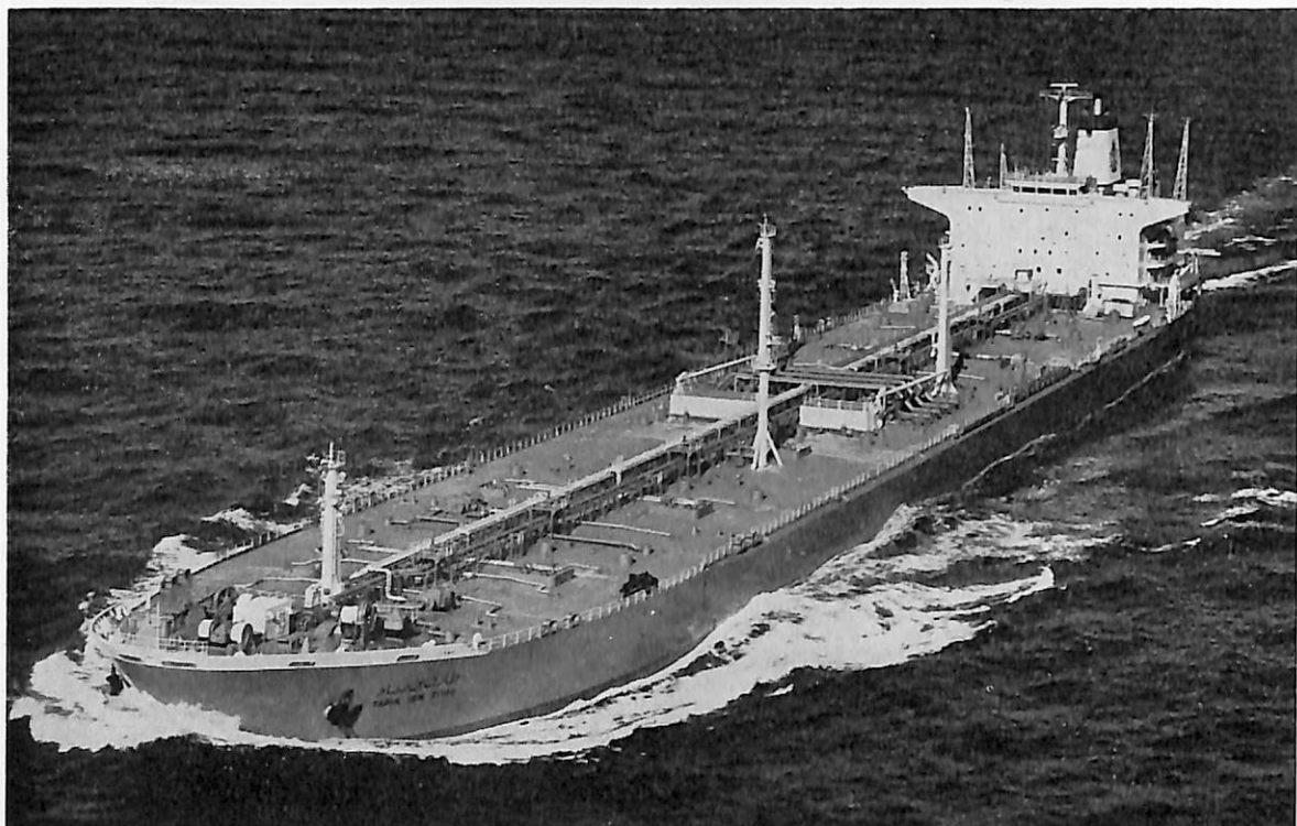
TARIK IBN ZIYAD (油槽船) 船主 Iraq National Oil Company. (イラク) 造船所 三井造船・玉野造船所 総噸数 61,689.80噸 純噸数 43,270.65噸 遠洋 船級 NK 載貨重量 118,134噸 全長 257.00m 長(垂) 246.000 m 幅(型) 39.400m 深(型) 22.400m 吃水 16.913m 満載排水量 138,149噸 平甲板船 主機 三井B&W 7 K90 GF型ディーゼル機関1基 出力 21,700BPS×110RPM 燃料消費量 84.02t/d 航続距離 17,090海里 速力 15.7 ノット 汽罐 三井WTA 60, 2胴式水管ボイラー-60,000kg/hr×16.5kg/cm 2 G×1 発電機 ディーゼル 560KW×2 貨油倉 143,842.6m 3 清水倉 286.5m 3 燃料油倉 F 4,177.8m 3 D 303.4m 3 乗員 43名 工期 49-7-26, 49- 10-8, 50-1-29
