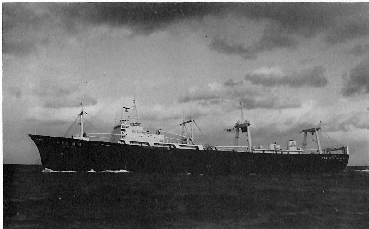
DAEJIN No 52 (遠洋トロール漁船) 船主 大林水産(大韓民国) 造船所 (株)新潟鉄工所新潟造船工場 総噸数 4,054.72噸 純噸数 2,370.00噸 船級 KR 載貨重量 3,287.50噸 全長 103.70m 長(垂) 94.00m 幅(型) 16.00m 深(型) 9.90m 吃水 6.066m 満載排水量 5,960.85噸 主機 神戸発動機6UET45/80 D型ディーゼル機関1基 出力 3,825PS×218RPM 燃料消費量 155g/ps.h 航続距離 16,900海里 速力 13.5ノット 発電機 625 KVA×3 原動機 6L20A×750PS×900r/m 漁倉その他(ペール) 2,171.01m 3 (グリーン) 2,299.54m 3 清水倉 135.79m 3 燃料油倉 1,227.98m 3 乗員 146名 工期 49-3-15, 49-9-5, 49-12-16
