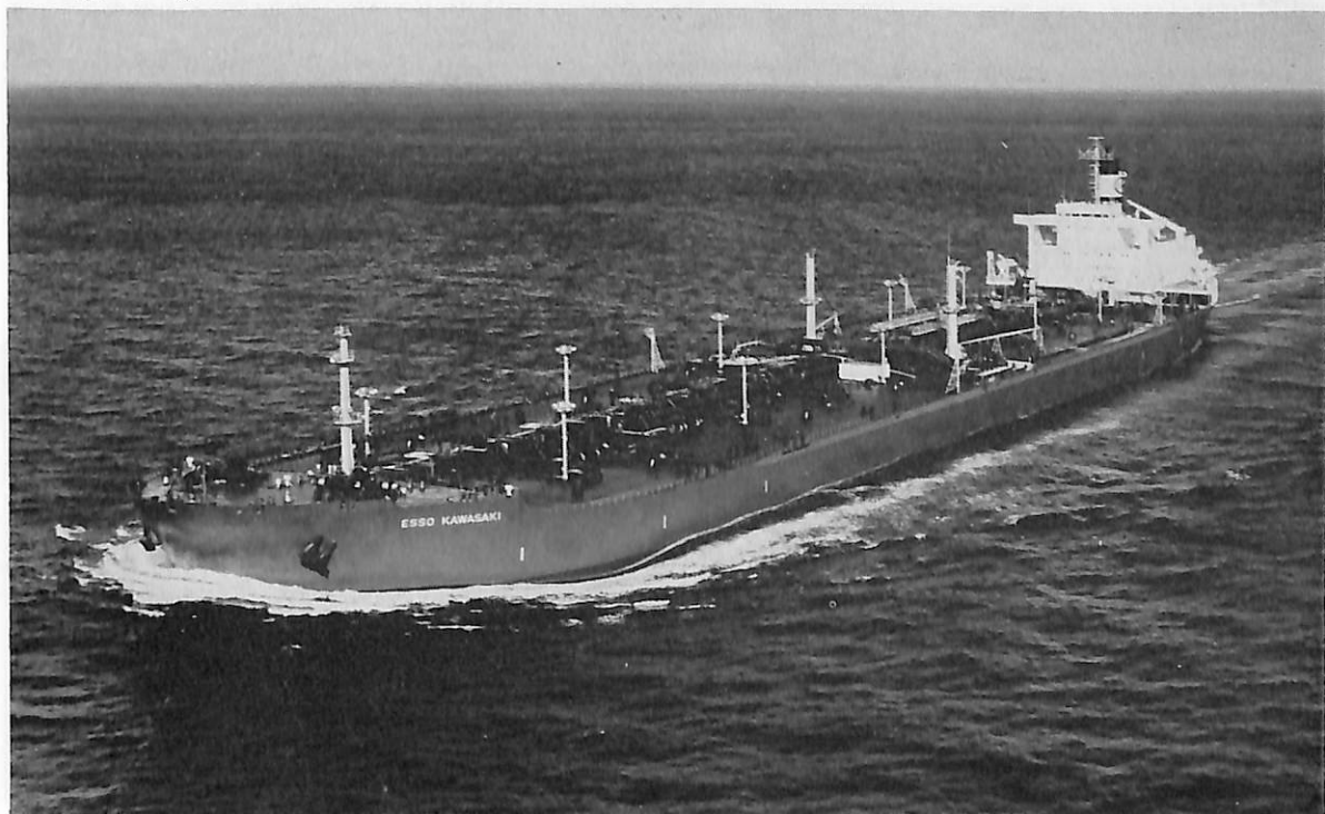
ESSO KAWASAKI (油槽船) 船主 Esso Tankers Inc. (リベリア) 造船所 川崎重工業・坂出工場 総噸数 138,113.72噸 純噸数 114,215噸 遠洋 船級 AB 載貨重量 307,432噸 全長 340.00m 長(垂) 325.00m 幅(型) 56.00m 深(型) 28.80m 吃水 22.427m 満載排水量 351,610噸 船首楼付平甲板型 主機 川崎UA 360型タービン1基 出力 36,000PS×82RPM 燃料消費量 179.1t/d 航続距離 24,300海里 速力 15.93ノット 汽罐 川崎UMG75/57, 2胴水管式2基 発電機 2,200kW 2,750KVA, AC 450V, 480kW 600KVA, AC 450V 原動機タービン×2 ディーゼル×1 貨油倉 376,315.79m 3 清水倉 382.76m 3 燃料油倉 12,322.64m 3 乗員 50名 工期 49-5-7, 49-8-2, 49-12-10 30万トンタンカーの第一番船
