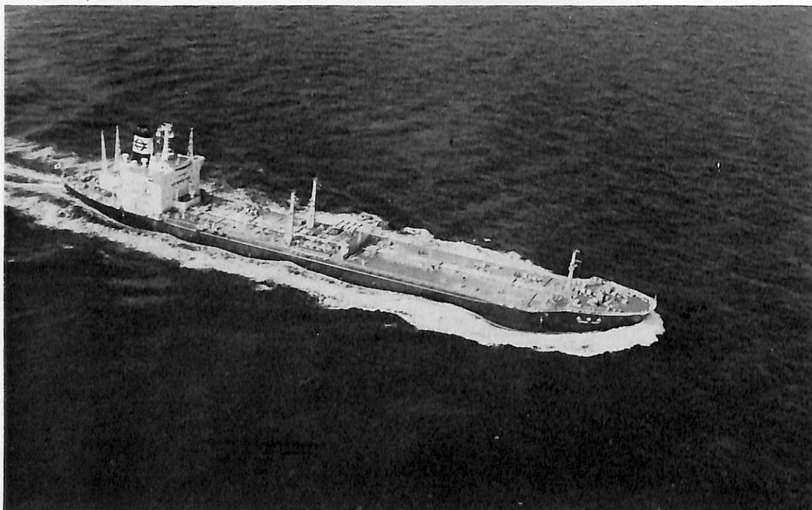
天 晴 丸 (油槽船) 船主 天晴汽船株式会社 造船所 常石造船株式会社 総噸数 20,865.86噸 純噸数 12,858.89噸 遠洋 船級 NK 載貨重量 36,665噸 全長 189.00m 長(垂) 180.00m 幅(型) 27.00m 深(型) 14.95m 吃水 11.024m 満載排水量 45,141噸 船首楼付平甲板型 主機 三井B&W 6K 84EF型ディーゼル機関1基 出力 14,000PS×110RPM 燃料消費量 52.6t/d 航続距離 11,200海里 速力 15.6 ノット 汽罐 三井2胴式水管ボイラー 32,000kg/hr×1 発電機 610KW×2 原動機 915PS×720rpm 貨油倉 44,606.5m 3 清水倉 404.5m 3 燃料油倉 F 1,781.8m 3 D 225.6m 3 乗員 28名(予備3, 旅客1) 工期 49-6-13, 49-9-15, 49-12-26
