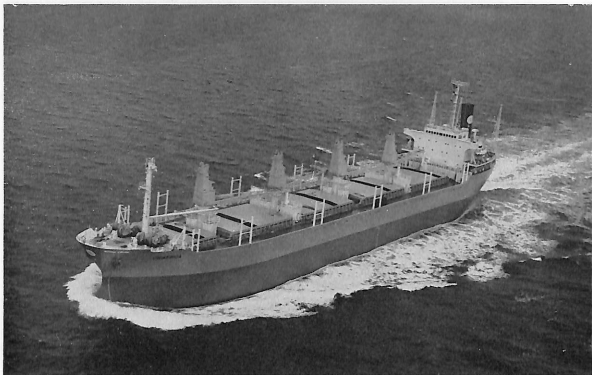
UNIAFRICA (ばら積貨物船) 船主 Africa Carriers Inc. (リベリア) 造船所 今治造船・丸亀事業本部 総噸数 15,875.07噸 純噸数 9,895.75噸 遠洋 船級 BV 載貨重量 29,672.00噸 全長 175.168m 長(垂)165.00m 幅(型) 26.00m 深(型) 14.50m 吃水 10.300m 満載排水量 37,146.6噸 ウェル甲板型 主機 三菱スルザー 7 R ND68型ディーゼル機関1基 出力 10,395PS×145RPM 燃料消費量 37.72t/d 航続距離 17,500海里 速力14.50 ノット 汽罐 コクランコンポジット型 7.0kg/cm 2 800kg/h 発電機 400KVA×3 原動機 470PS×900RPM×3 貨物倉(ベール) 35,205.0m 3 (グリーン) 36,393.0m 3 清水倉 390.36m 3 乗員 32名 工期 49-2-25, 49-10- 6, 49-12-19
