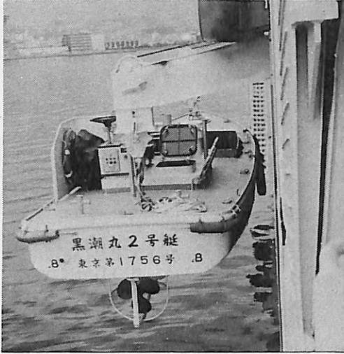
降下作業中の作業艇
