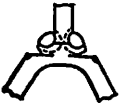
(ロ) ワレが止端または熱影響部より発生し、試験材表面と直角には進行しない場合で、試験材にマイクロミネーションが存在するか、熱影響部の硬化がいちじるしく、アンダービードクラックを生じやすい場合が多い。
