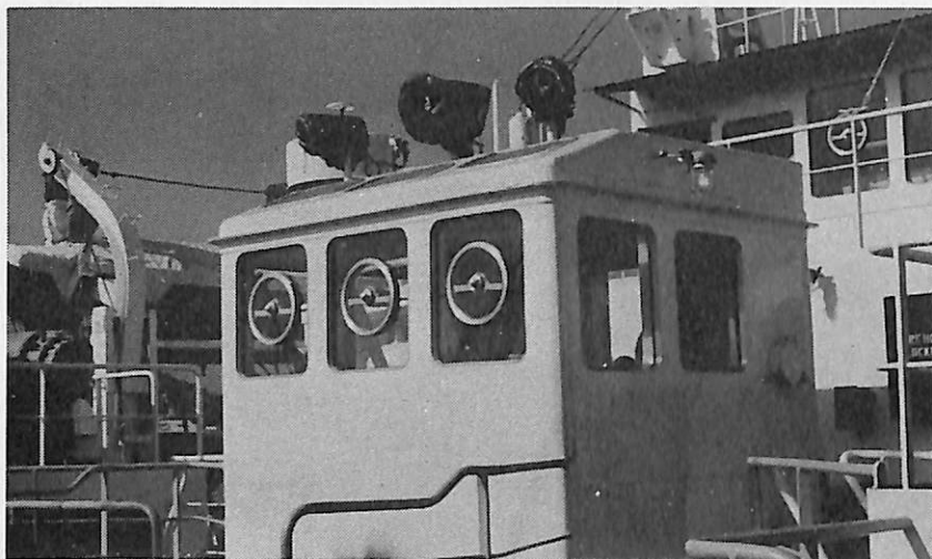
トロール・ウインチ ・コントロール室
