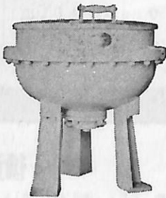
ライスボイラー
