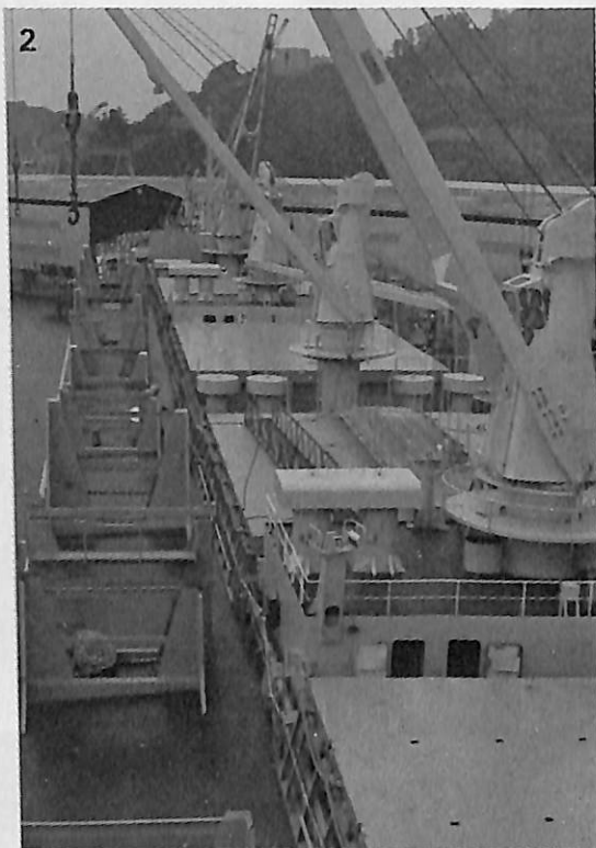
写真②上甲板全景。ランプウェイがハッチウェイにあるために、各サイズのボンツーンに合うように色わけされたボンツーンラック。ハッチカバーは、カヤバ製シングルプル型で、No.1ハッチは油圧トルクヒンジアクチュエーター作動、No.2から5まではクレーンで操作される。
