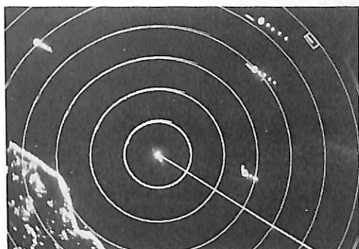
写真一2 現在4隻を追跡し、プロット中。 右上の四角はガードリングに自動捕捉された状態を示す。
