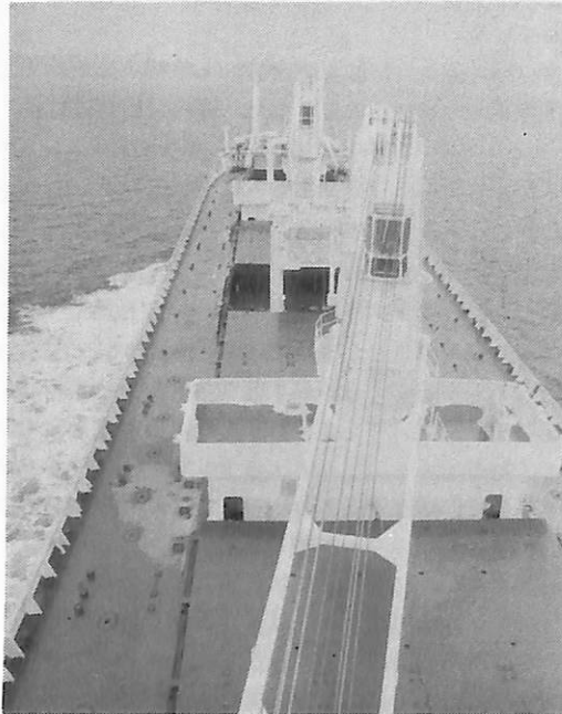
上甲板全景。10.5 t ツインクレーン (辻産業製) が 2 基搭載されている。
