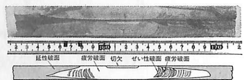
図10-98 ポップイン現象を含む疲労試験片破面 38)
