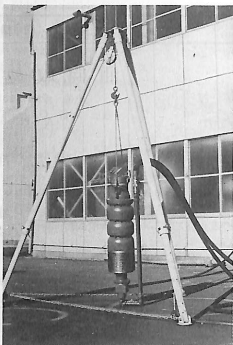
サブマージブルポンプとアルミ製トライポッド
