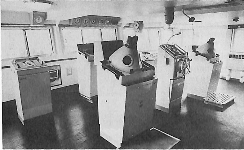
衝突予防レーダ、オメガ、ロラン、デッカ、ドップラーソナなど一般船舶向きの計器類を装置している。
