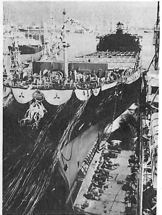
2月25日——進水する“春日丸”。船台幅一杯の本船を無事進水させるために慎重な計画がたてられて実行された
