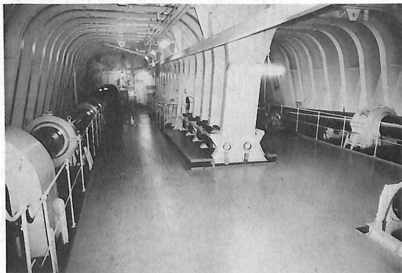
機関室は3フレーム・スペース短縮されはしたが、機能面と保守面で不都合を生じない配慮が加えられた。シャフト抜きの際のスペースも十分に考慮されている。
