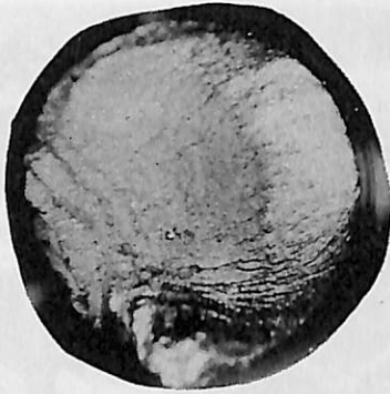
写真3 回転曲げ疲労破壊の破断面
