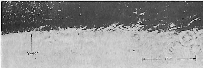
層流から乱流境界層への遷移。Polyox WSR-301 500 ppm: V=6\text{ m/s} 。供試模型: 回転対称体頭部 (直径 1 cm)。流れの可視化: 2% NaCl 溶液の注入
