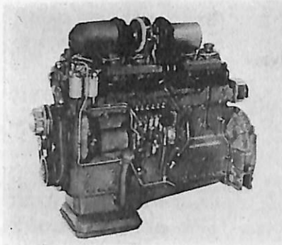
(r) Volvo TD120A 6—130×150 282ps/2,000rpm
