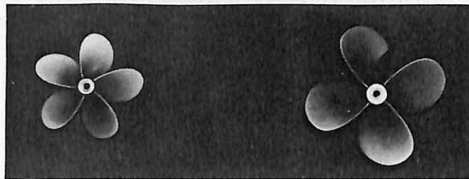
写真2 船尾付近の流れの状況と同実験に使用した模型プロペラ
