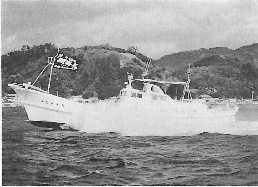
図7 実用テスト中のFRP漁船
