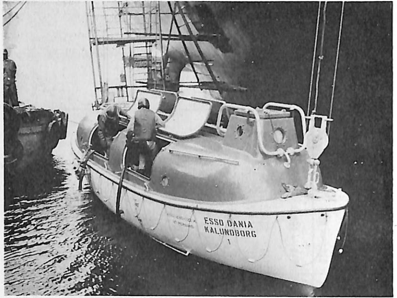
写真1(右) タンカーに搭載されたFRP製耐火救命艇 写真2(下) T.No. I 開始前
