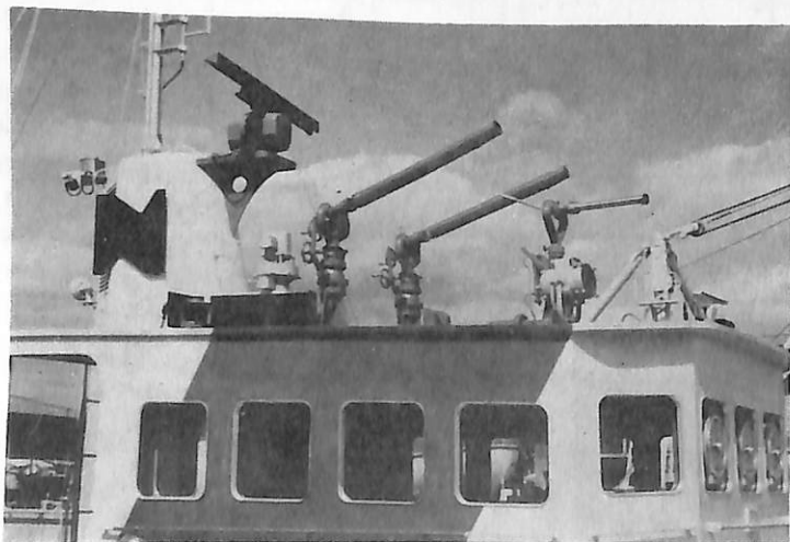
消防用放水銃，大型2基は水および泡消火用。小型は粉末放射用。
