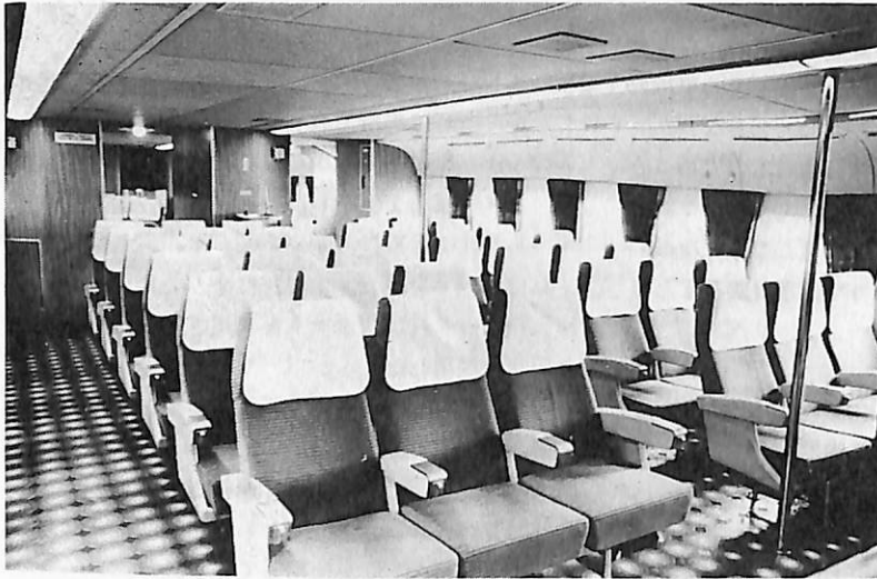
客室C 中間肘掛ははね上げ式。また 頂部コーナーに空気吹出 し口がある
