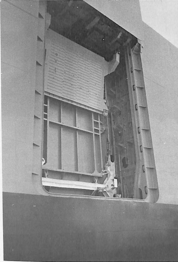
右舷のサイドポートとカーラダー。サイドポートは開きの状態
