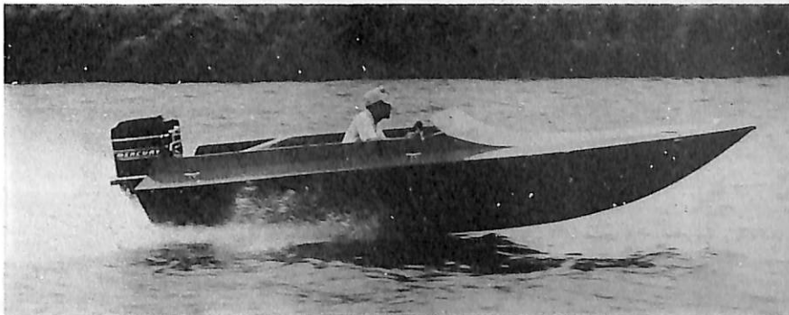
S/N16F/(財)舟艇協会が昭和50年、自作技術研究のため試作したランナバウト。全長4.99m、航走速度83km/h
