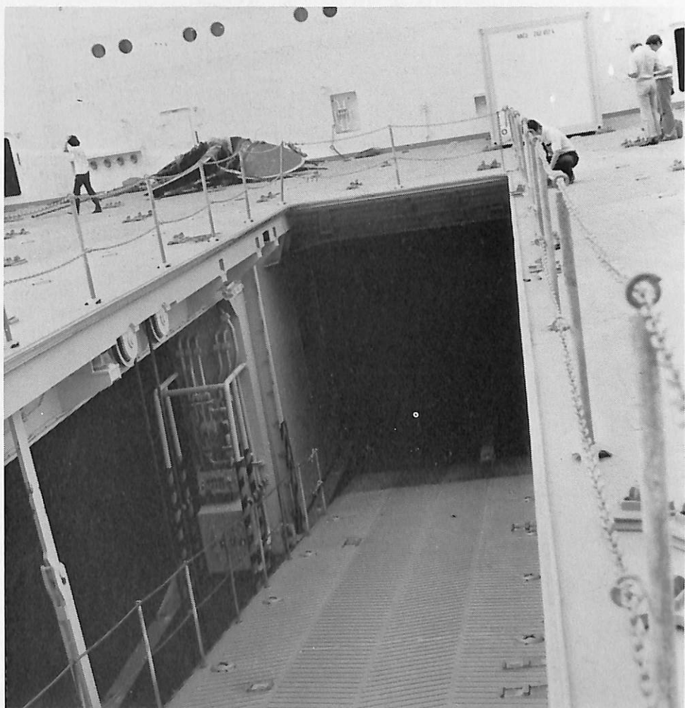
Movable ramp upper deck から 2nd deck 上に hinge down した状態を示す。upper deck と 2nd deck 間の車両走行路
