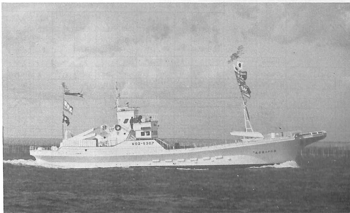
199t型鰹一本釣漁船 / 西井造船が昭和52年2月に建造したわが国で最大のバルサ・サンドイッチFRP構造船。全長35m800、深さ2m65、吃水2m40、速度12.8ノット。
