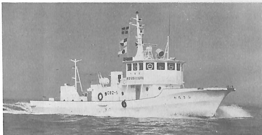
ふさなみ / IHI 舟艇工場が昭和52 年建造した千葉県 の漁船安全操業指 導船。全長26m、 速度18ノット。
