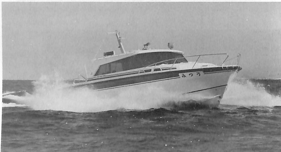
うつみ/石原造船 が昭和49年建造したクルーザー。瀬戸内海で交通艇として使用されている。全長15.5m、航走速度23.6ノット。
