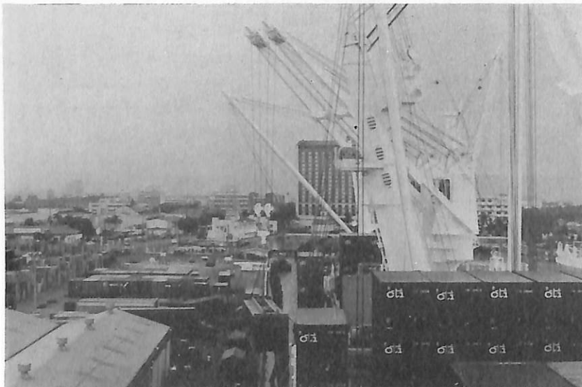
ナビゲーション・ブリッジ左舷側より船首を見る。ツインクレーンによるコンテナローディング中
