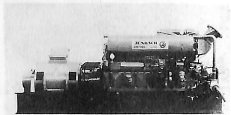
図6.12.4.53 (F) MWM TBD602V16 の外観 16V—160×165, 1,415PS/1,500rpm
